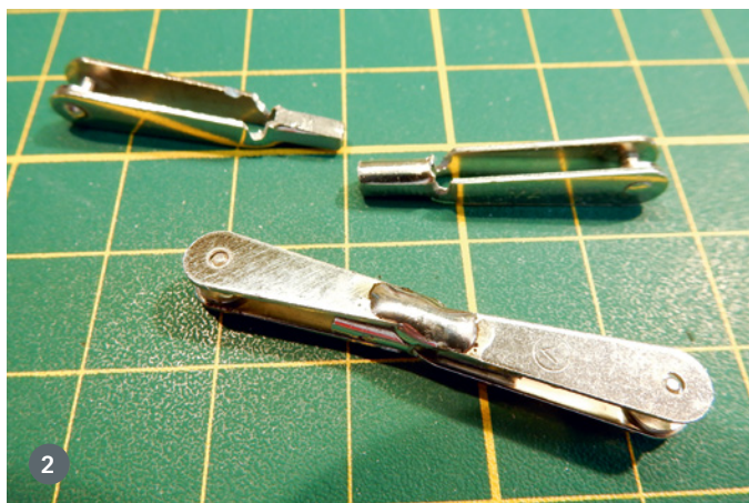
1) Die Ruderhörner der Querruder und Wölbklappen werden in den vorgefertigten Schlitz eingefädelt, eingerastet und mit Epoxy verklebt. 2) Für die Querruderanlenkung werden zwei Gabelköpfe ineinander verhakt und verlötet
