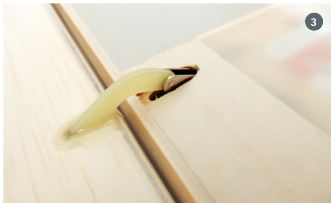
3) Dieses Konstrukt führt zu einer steifen und spielfreien Anlenkung. 4) Auf der Unterseite steht später nichts über, was sich im Gras verhaken kann
