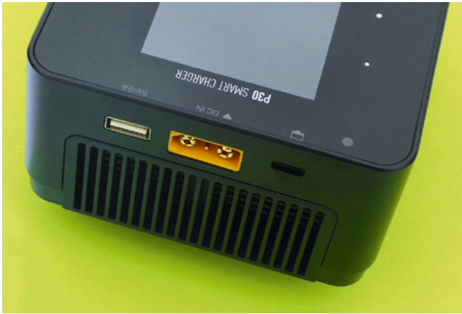
Das hochwertige Gehäuse ist aus Aluminium gefertigt. Der DC-Eingang, ein kräftiger Lüfter sowie zwei USB-Ports sind rückseitig untergebracht
