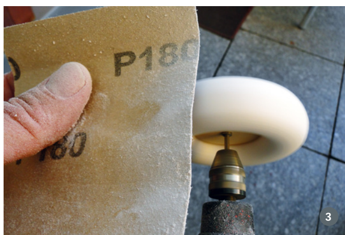
3) Eingespannt in die Mini-Bohrmaschine, kann man den Rädern mit Sandpapier eine abgeflachte Form verpassen. 4) Die Räder sind hier schon mit einer Kunststoff-Laufbuchse versehen und schwarz gestrichen. Die frisch aufgetragene Beschichtung aus wasserfestem Weißbleim trocknet transparent aus, sorgt für Festigkeit und ist später kaum noch zu sehen
