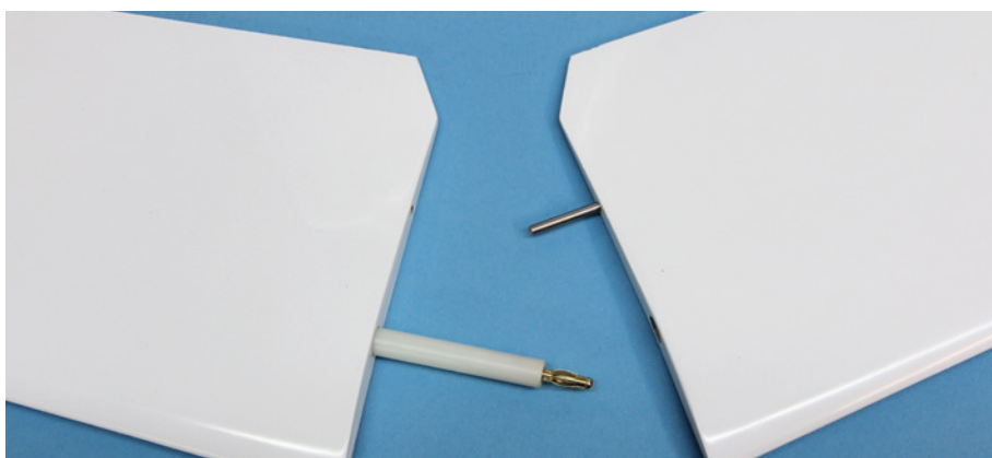
Über einen integrierten 4-mm-Goldstecker wird das Höhenruder zusammengehalten und damit sicher am Rumpf befestigt
