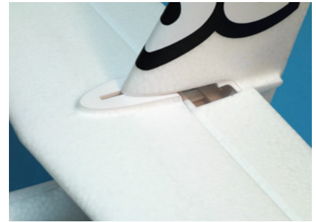
Das Höhenleitwerk wird von vorne auf das Seitenleitwerk aufgeschoben
