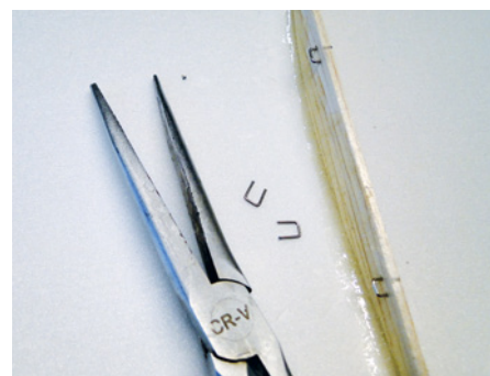
In die Hilfsrippen werden kleine Drahtwinkel zur Befestigung der Streben eingearzt
