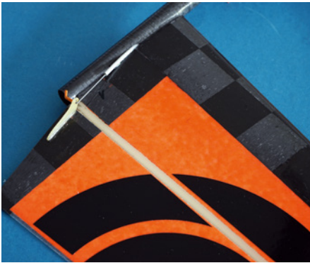
Das Seitenleitwerk ist ab Werk auf dem CFK-Heckausleger befestigt und das Ruder betriebsbereit aufgebaut
