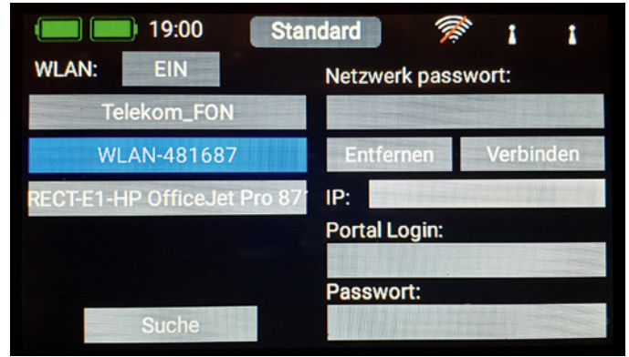
Hier die im Text beschriebene Eingabemaske der WiFi-Funktion, mit der sich die Anlage im verfügbaren WLAN einwählen kann. Das rechts unten angezeigte Portal ist zurzeit noch nicht aktiv, aber in Bearbeitung
