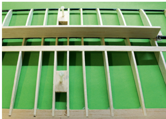
Der Spoiler hat ein Scharnier aus einem durchgehenden CFK-Stab erhalten, der außen in Blechstücken lagert
