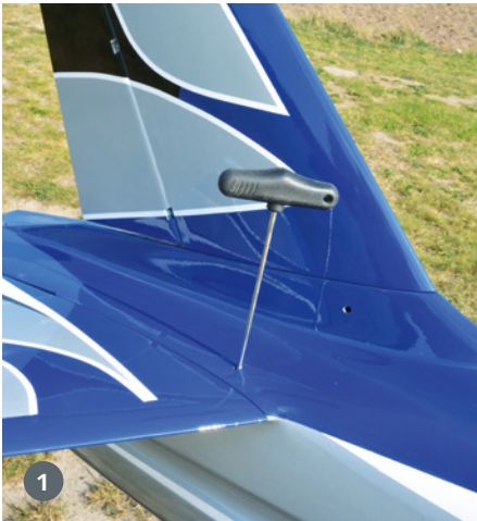
1. Über kleine Öffnungen werden die Spannschrauben für die Leitwerksbefestigung erreicht. 2. Die Servostecker der Leitwerke werden in fest verklebte Buchsen im Rumpf gesteckt
