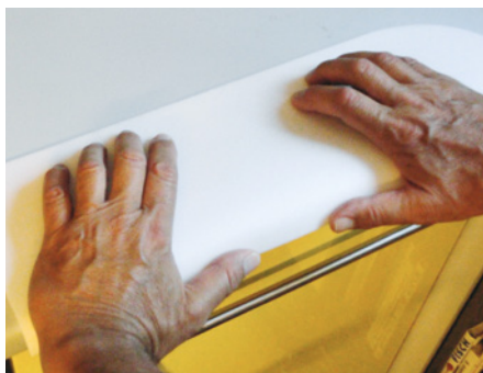
Durch vorsichtiges Walken über die Kante der Arbeitsplatte erhalten die Flügel ihr Hohlprofil
