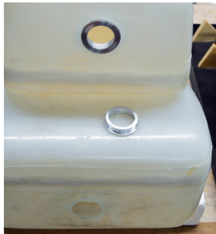
Diese Aluminiumringe wurden in Eigenarbeit erstellt, um im Tankausgang etwas mehr Festigkeit zu erhalten
