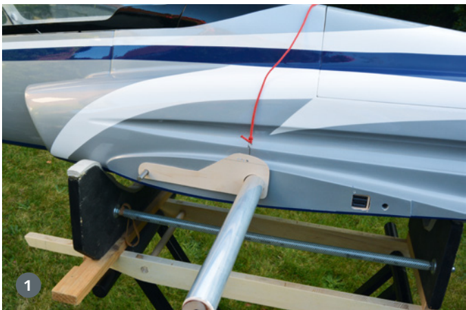
1. Da solch ein Modell nicht mehr auf den Fingerspitzen balanciert wird, um den Schwerpunkt festzustellen, haben wir diese einfache Vorrichtung angefertigt. 2. Damit kann das komplette Modell leicht an der geforderten Schwerpunktlage angehoben werden. Auch wird hier die Federwaage eingehängt, um das tatsächliche Gewicht zu ermitteln
