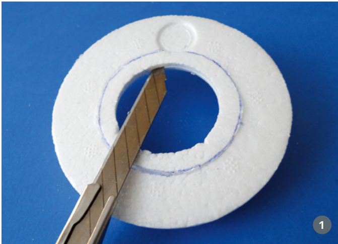
1) Die Deko-Ringe aus dem Bastelladen werden innen mit dem Cutter ausgespart. Erst ein senkrechter und dann ein waagerechter Schnitt.
