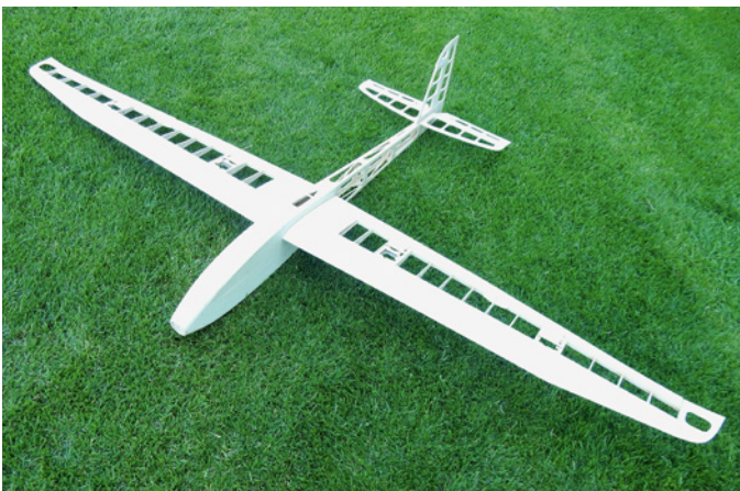
980 g bringt der Rohbau auf die Waage und ist super stabil
