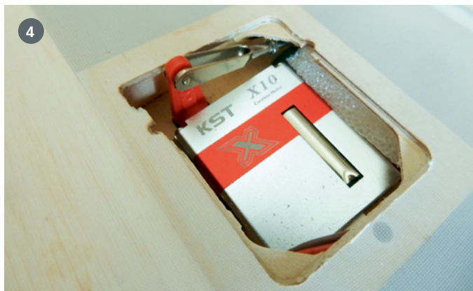
3) Dieses Konstrukt führt zu einer steifen und spielfreien Anlenkung. 4) Auf der Unterseite steht später nichts über, was sich im Gras verhaken kann
