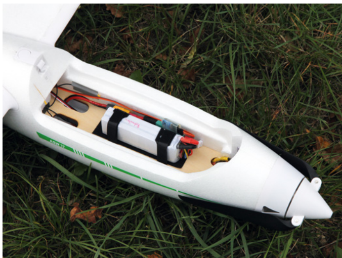
Nutzt man einen 3s-Akku, passt die herstellerseitig vorgesehene Akkuposition
