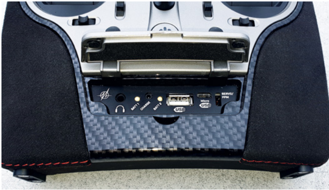
Unter der Klappe des Senders befinden sich die Buchsen für Kopfhörer, Ladekabel und 2 x USB sowie ein PPM-Ausgang, beispielsweise für den Anschluss eines Servos oder S.Bus2-Empfängers bei Einsatz der Lehrer-Schüler-Funktion mit einem Fremd-Sender
