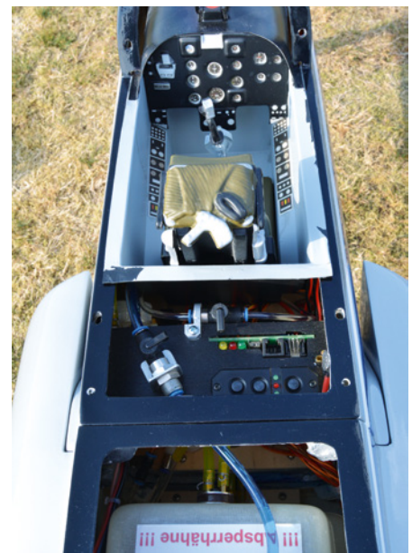
Blick auf das Bedienpanel mit den beiden Absperrhähnen, dem GSU-Anschluss für die Turbine, dem PowerBox-Schalter und dem Stecker für die Stromversorgung des Fahrwerks
