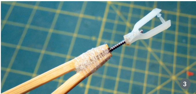
3) Die Flächenstreben haben unten eine Gewindestange eingesetzt bekommen, so lässt sich die V-Form der Tragflächen genau einstellen. 4) Am Flügel sind die Streben mit kleinen Drahthaken befestigt, die mit Schrumpfschlauch an den Bambusstäbchen fixiert sind. Ein Tropfen Uhu por verhindert, dass die Haken aus den Drahtwinkeln rutschen
