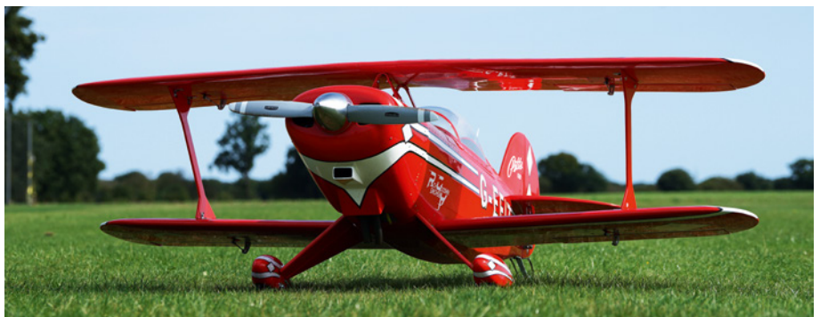
Zugunsten einer schnellen Montage auf dem Platz entfällt eine Verspannung und Flächenstreben sowie Baldachin sind bewusst einfach gehalten
