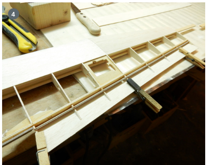
3) Erst wenn das Gerippe auf die Unterbeplankung der D-Box gesteckt ist, wird es mittels Servobrettchen sauber ausgerichtet und verklebt. 4) Die Ruderflächen werden zusammen mit dem Flügel gebaut
