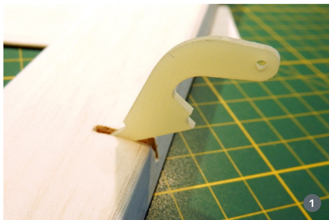
1) Die Ruderhörner der Querruder und Wölbklappen werden in den vorgefertigten Schlitz eingefädelt, eingerastet und mit Epoxy verklebt. 2) Für die Querruderanlenkung werden zwei Gabelköpfe ineinander verhakt und verlötet
