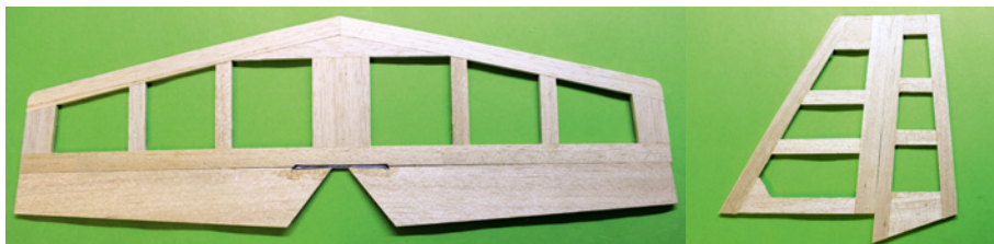
Beide Leitwerke sind aus Balsa zu erstellen und ergeben eine solide Konstruktion
