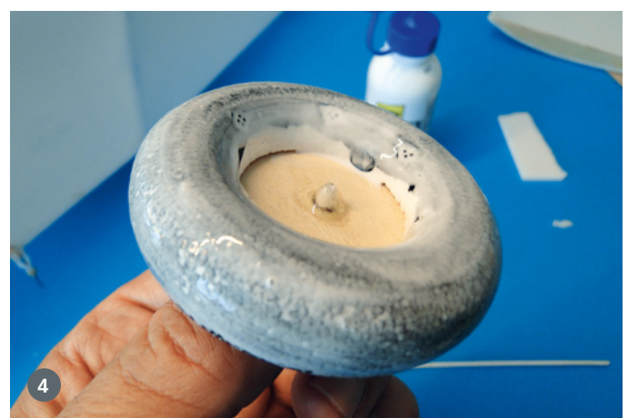
3) Eingespannt in die Mini-Bohrmaschine, kann man den Rädern mit Sandpapier eine abgeflachte Form verpassen. 4) Die Räder sind hier schon mit einer Kunststoff-Laufbuchse versehen und schwarz gestrichen. Die frisch aufgetragene Beschichtung aus wasserfestem Weißbleim trocknet transparent aus, sorgt für Festigkeit und ist später kaum noch zu sehen
