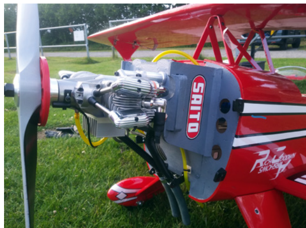
Unter der ab Werk fertig lackierten GFK-Motorhaube ist ein Saito FG 61 befestigt
