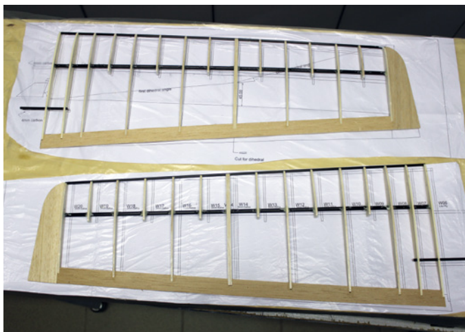
Beide Außenflügel sind so weit fertiggestellt, dass sie in der Mitte – bei den Rippen Nummer 14 – wieder getrennt und danach mit großer V-Form zusammengeklebt werden können
