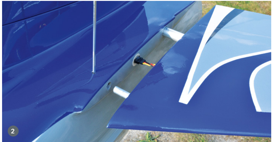
1. Über kleine Öffnungen werden die Spannschrauben für die Leitwerksbefestigung erreicht. 2. Die Servostecker der Leitwerke werden in fest verklebte Buchsen im Rumpf gesteckt
