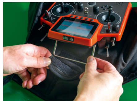
Sichert man den Tragebügel mit der Klettschleufe, hat der Sender guten Halt unter der Haube
