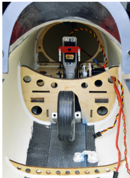
Der Bereich um die Bugfahrwerksklappe ist großflächig mit Kohle verstärkt
