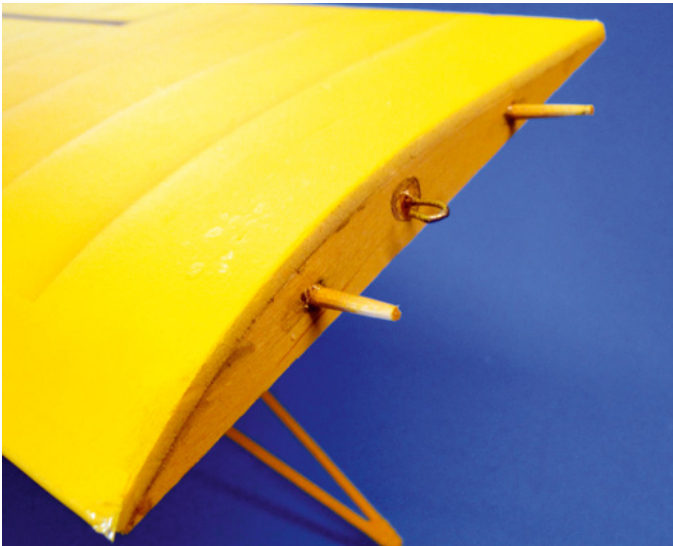
Haltedübel und ein Drahthaken für den Gummizug halten die Flügel am Rumpf
