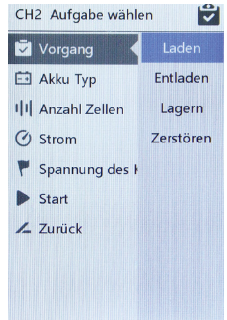
In diesem Menü wählt man den gewünschten Vorgang aus und anschließend gibt man die Parameter des zu ladenden Akkus vor
