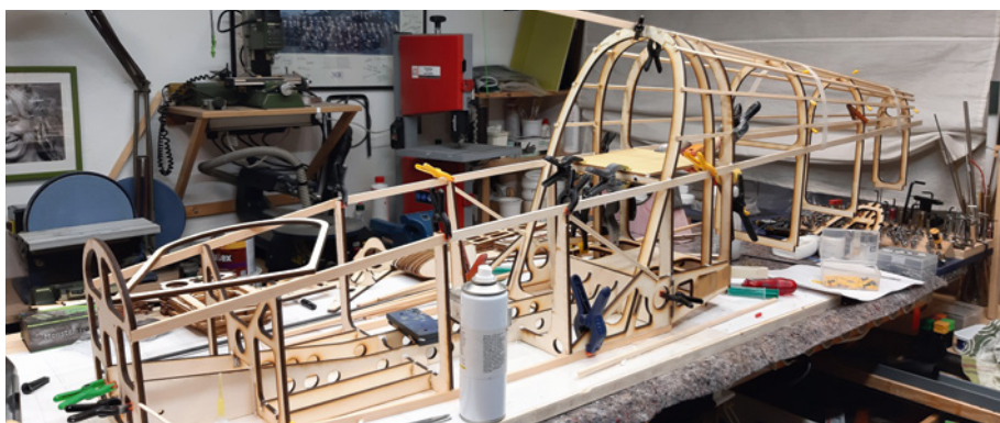
Klassischer Bau des Modells auf Spanten mit Gurten, Trägern, Platten und Verstärkungen
