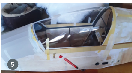
4) Anpassen des Flügels und der Wurzelrippe. Permanente Gewichtskontrolle ist das A und O. 5) Das Glück meinte es gut. Eine Fox-Haube passte beinahe perfekt auf die SubSonex. Hier wird gerade der Rahmen eingepasst. 6) Dünnes, leichtes Alu verleiht der Haube Steifigkeit und eine ansprechende Optik
