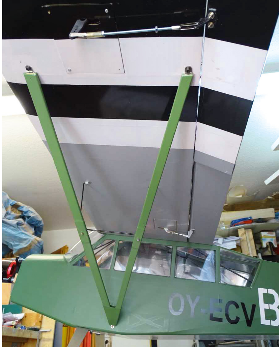
Damit alles den richtigen Halt hat, werden in Rumpf und Tragfläche Einschlagmuttern verbaut. Die Verbindung erfolgte mit M3-Schrauben und die Sicherung der Tragflächen durch M5-Schrauben mit gedrucktem Rändelkopf
