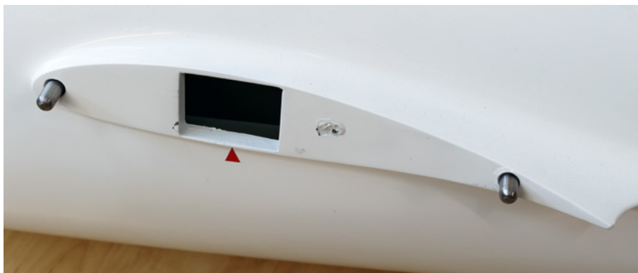
Hier zu sehen ist die Tragflächenaufnahme am Rumpf, die Aussparung für die Holmbrücke ist eingebaut, ebenso die Torsionsbolzen. Ein kleines rotes Dreieck symbolisiert den Schwerpunkt
