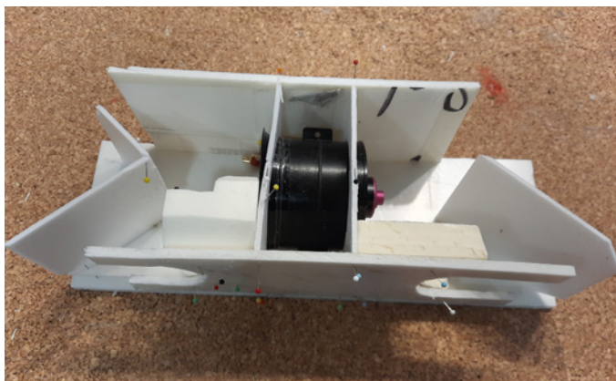
Zur Unterstützung der 3D-Konstruktion wurde zunächst eine Modellvorlage (Mock-up) gebaut, in der der Impeller sitzt
