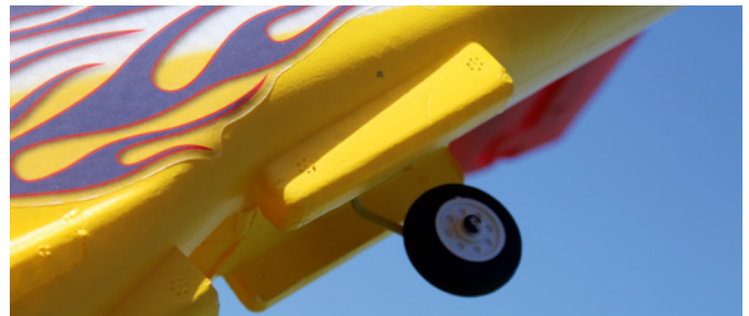
Der Hecksporn ist formal leider nicht so toll gelungen wie das übrige Modell und darüber hinaus auch nicht einziehbar
