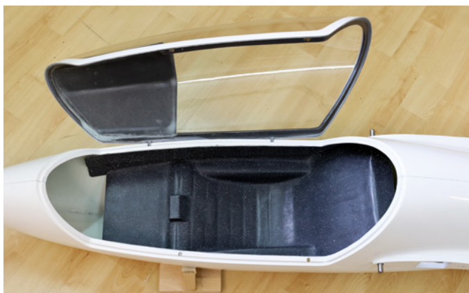
Die seitlichen Hauben-Scharniere sind ab Werk fertig eingebaut. Die Zuhaltung der Haube soll mit zwei Magneten realisiert werden. Hier wird die spätere Erprobung zeigen, ob dies praxistauglich ist
