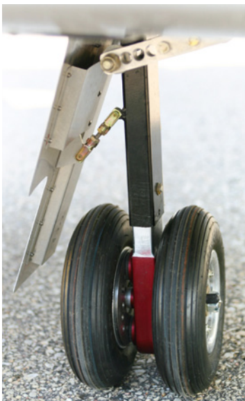
Am PC entstanden zahlreiche Bauteile zunächst als CAD-Teil und wurden anschließend nachgebaut. Die Räder stammen übrigens von Inlineskates
