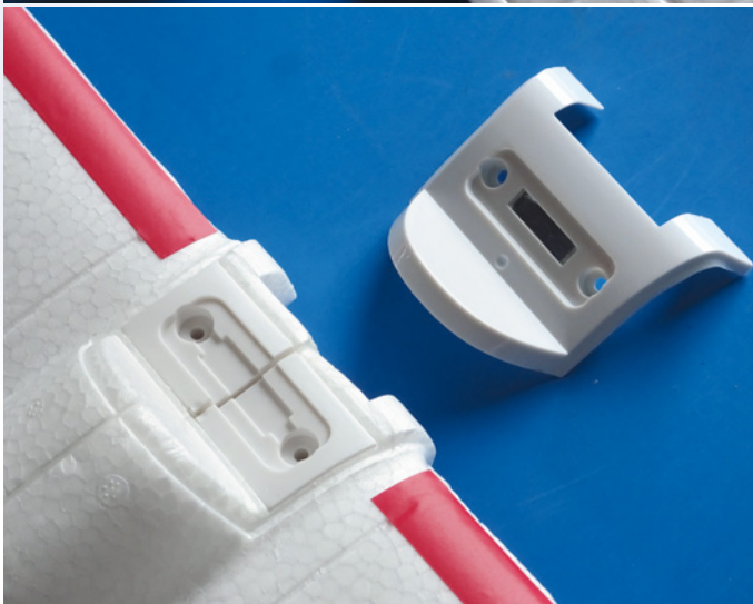
Stabile Kunststoffteile sorgen für sicher am Rumpf befestigte Flächenhälften, die von Schrauben fixiert werden
