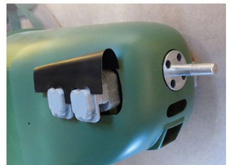
Etwas Blech und Zylinderköpfe aus dem 3D-Drucker werten das Erscheinungsbild auf
