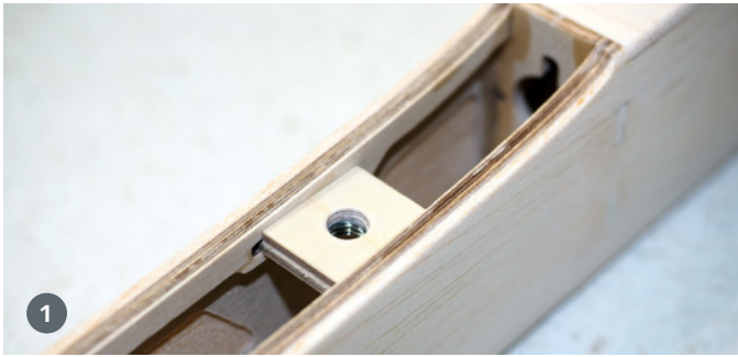
1) Hier muss man gegebenenfalls noch einmal mit der Rundfeile die Bohrungen nachbessern, damit die M5-Nylonschraube am Ende auch passt. 2) Verkleben, Schleifen, Streichen und Verbinden: Aus drei Balsateilen besteht der Leitwerks-tragende Pylon. Die Strecken A und B sollen am Ende gleich lang sein
