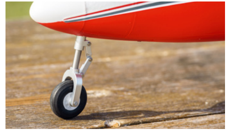
Komplett aus Metall gefertigt, optisch ansprechend und auch auf Graspisten solide: das gefederte und gelenkte Bugfahrwerk
