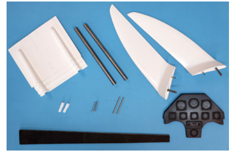
Die mitgelieferten Kleinteile beschränken sich auf die Servoabdeckungen, die CFK-beschichtete Seitenruderabschlussleiste, ein Instrumentenbrett, die Hohlkehlscharniere für das Seitenruder, sowie die Flächensteckung für die Außenflügel und natürlich die Winglets
