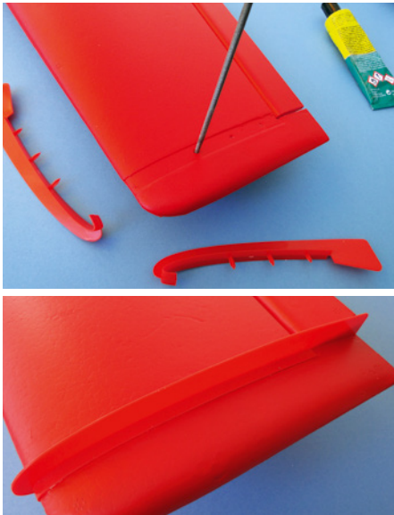
Die Vertiefungen zur Aufnahme der Grenzschicht-Zäune weiten wir noch etwas mit der Feile auf, verklebt wird mit Uhu Por
