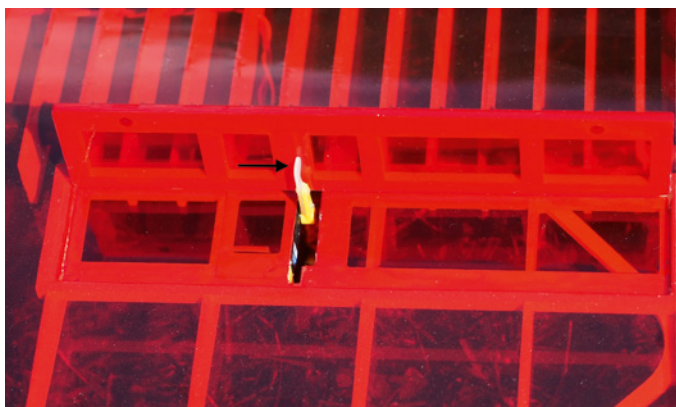
Abweichend von der Bauanleitung wurden die Bremsklappen in den Tragflächen bespannt. So wird der offene Flächenbereich bei hochgefahrenen Spoilern geschützt
