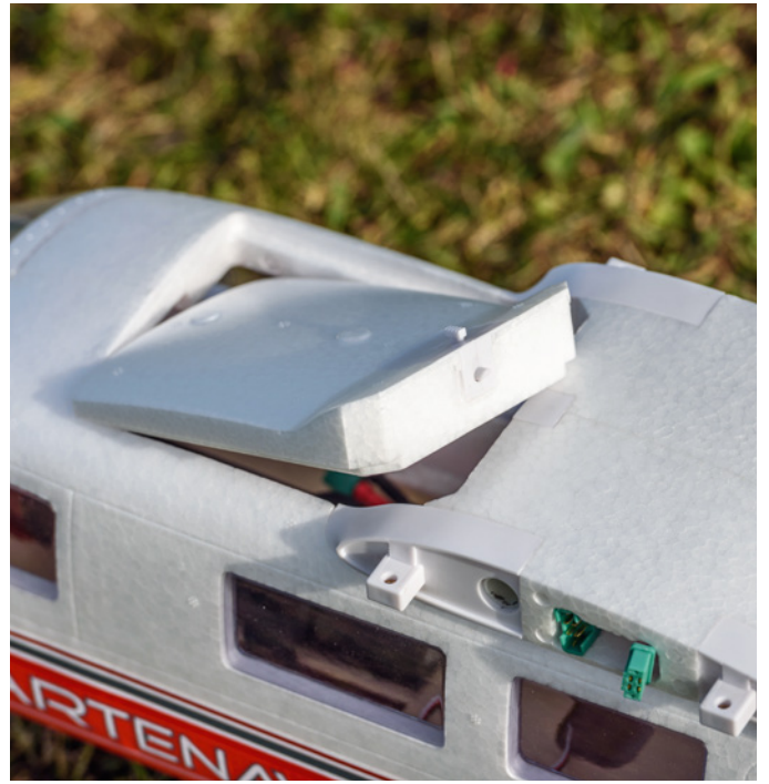
Die Zugangsklappe zum Akkuschatz ist sicher verriegelt im Tragflächen-Mittelteil
