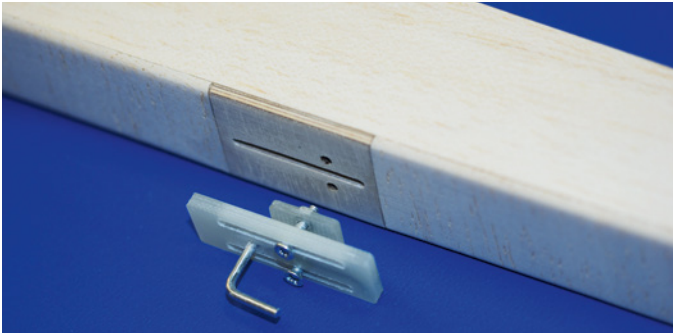
Eine Besonderheit ist der stufenlos verstellbare Hochstarthaken
