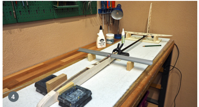
3) Die auf dem Bild dargestellten Verklebungen am Leitwerk zeigen die hohe Passgenauigkeit der Frästeile. Die Streben vom Leitwerk wie auch die Rippen der Tragfläche wurden lediglich mit einem 320er-Schleifklotz zuvor einmal „gestreichelt“. 4) Hilfskonstruktion: Dank Bauanleitung und Alu-U-Profil lassen sich Tragfläche und Höhenleitwerk gut zueinander ausrichten
