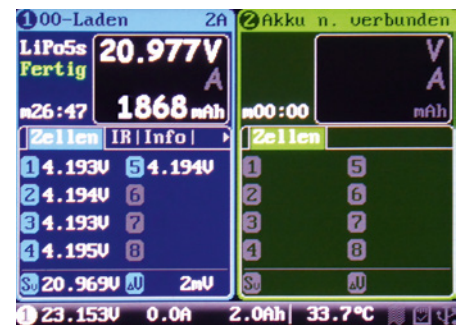
Der teilweise angeschlossene 5s-Akku ist voll aufgeladen und gut balanciert
