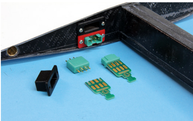
In den Wurzelrippen kleben wir die passenden Halter für die Hochstromstecker ein. Die Gegenstecker werden später mit Lötplatinen und Geflechtschlauch versehen, um die losen Kabel bestmöglich zu schützen
