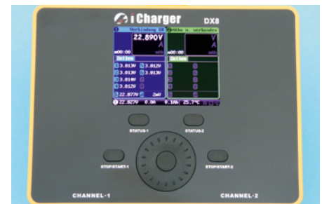
Das Display liegt gut im Blickfeld und lässt sich aus allen Perspektiven gut ablesen, die Bedienelemente sind übersichtlich angeordnet
