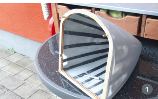
1) Die riesige GFK-Nase ist mit zahlreichen Rovings versteift. Goldkontakte sorgen für eine solide Steckung. 2) Anpassen des Übergangs Nase zu Rumpf. 3) Der Bauplan trug wesentlich zum exakten Fertigen des mit 550 mm Flächentiefe großen Flügels bei
