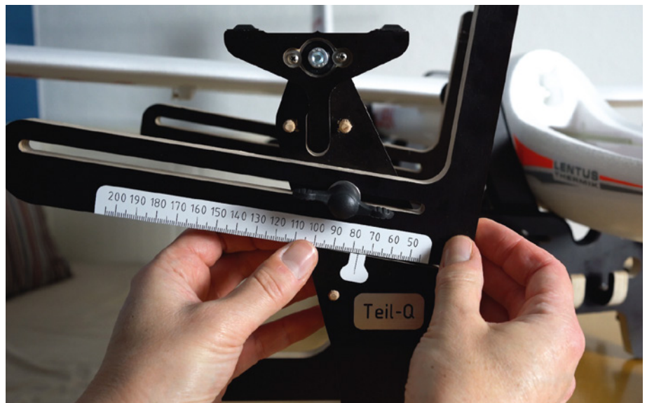
Schwerpunktwaagen helfen beim Einstellen der korrekten Schwerpunktlage
