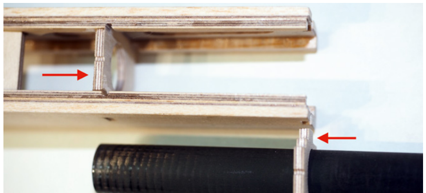
Hier besonders sorgfältig arbeiten! Das Rumpfrohr nur mit wenig Spiel den Markierungen nach in die Spanten einpassen. Als Lohn erhält man eine korrekte EWD
