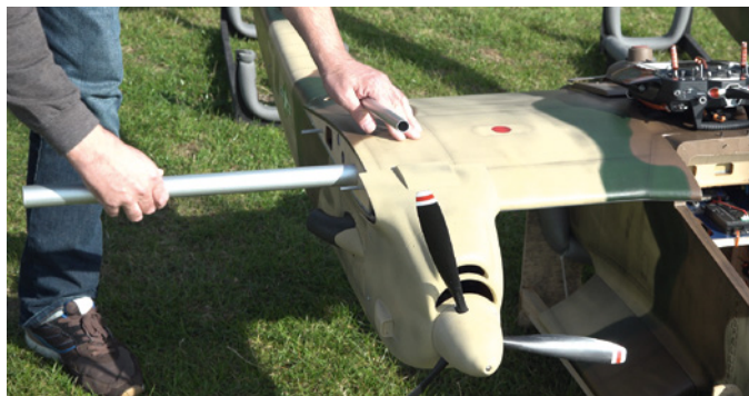
Das Modell besteht aus sieben Segmenten, ist damit transportfreundlich und gut aufzubauen
