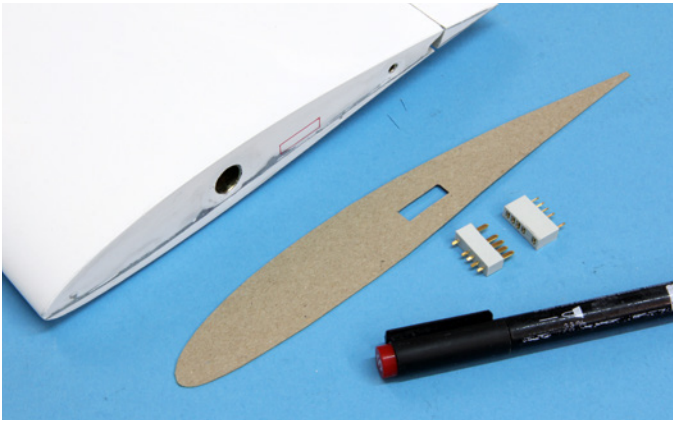
Um die korrekte Lage der Servostecker zu ermitteln, haben wir uns Schablonen angefertigt
