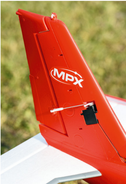
Leichte Abzüge in der Optik gibt es für das gänzlich unverkleidete Seitenruder-Servo. Eine rote Klebefolie hätte die Rudermaschine verkleidet – schade
