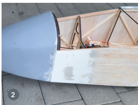
1) Die riesige GFK-Nase ist mit zahlreichen Rovings versteift. Goldkontakte sorgen für eine solide Steckung. 2) Anpassen des Übergangs Nase zu Rumpf. 3) Der Bauplan trug wesentlich zum exakten Fertigen des mit 550 mm Flächentiefe großen Flügels bei
