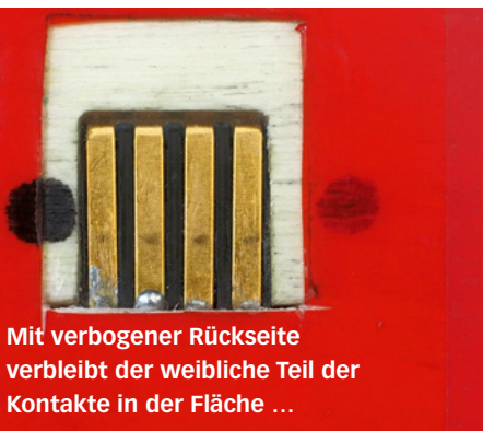
... und muss zu diesem männlichen Part später unbedingt richtig gepolt sein
