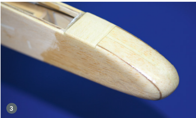
1) Mit kleinen Helfern wie diesen Balsaholz winkeln wird der Aufbau gut unterstützt und die Rippen lassen sich erfolgreich schrägen. 2) Gewichte halten die leicht gebogene Nasenleiste der Außenteile beim Verkleben mit den Rippen in Form. 3) Durchgängige Verstärkung: Die Nasenstabilität wird durch Sperrholz deutlich verbessert. 4) Filigran und flink: Der Lötvorgang hat es durchaus in sich
