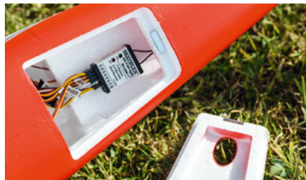
Auf der Rumpfunterseite macht es sich der Sieben-Kanal-Empfänger unter einer magnetisch gehaltenen Klappe bequem
