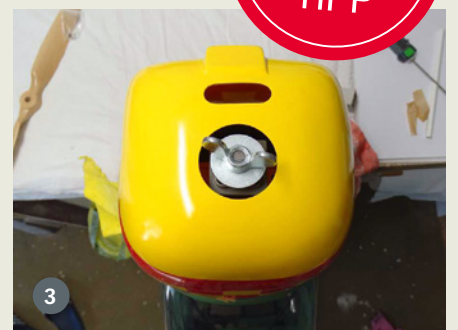
3 Dank der Schablone konnte der Antrieb mittig ausgerichtet werden
