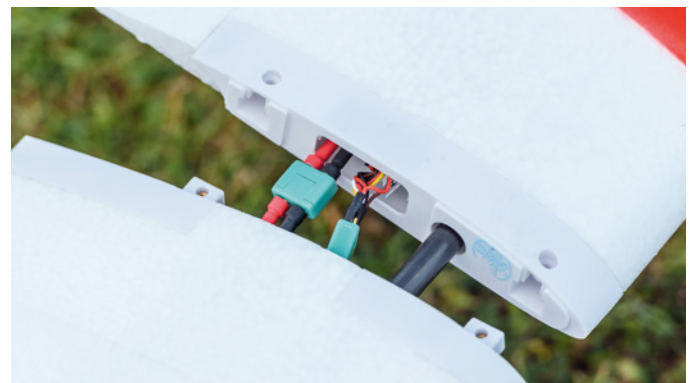
Zwei Multiplex-Steckverbinder verbinden Servos, Regler und Beleuchtung in den Tragflächen mit der Rumpf-Elektrik. Es ist knapp, lässt sich aber gerade noch so gut montieren
