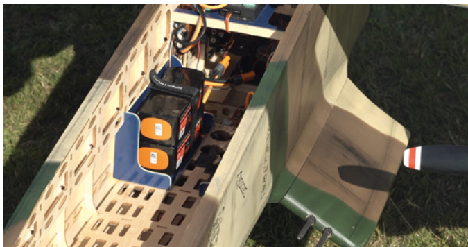
Vier 6s-LiPos im Haupttrumpf ergeben das 12s-Setup des Antriebs
