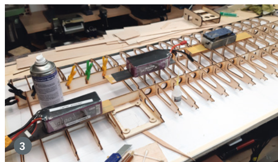
1) Die riesige GFK-Nase ist mit zahlreichen Rovings versteift. Goldkontakte sorgen für eine solide Steckung. 2) Anpassen des Übergangs Nase zu Rumpf. 3) Der Bauplan trug wesentlich zum exakten Fertigen des mit 550 mm Flächentiefe großen Flügels bei
