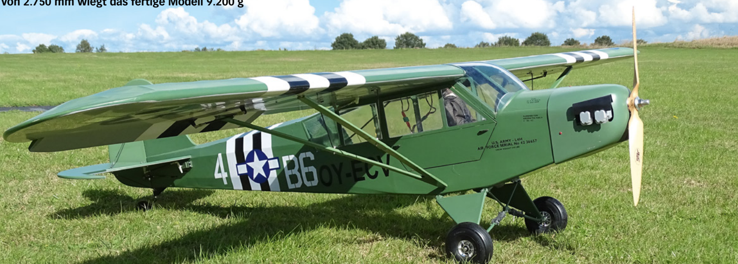
Bei einer Länge von 1.720 mm und einer Spannweite von 2.750 mm wiegt das fertige Modell 9.200 g
