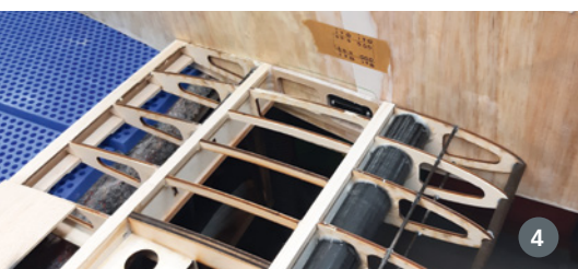
4) Anpassen des Flügels und der Wurzelrippe. Permanente Gewichtskontrolle ist das A und O. 5) Das Glück meinte es gut. Eine Fox-Haube passte beinahe perfekt auf die SubSonex. Hier wird gerade der Rahmen eingepasst. 6) Dünnes, leichtes Alu verleiht der Haube Steifigkeit und eine ansprechende Optik
