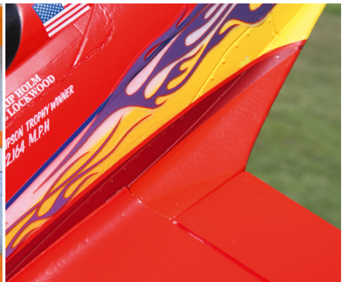
Mit ein bisschen Sprühlack haben wir den Rumpf-Flächen-Übergang originalgetreuer gestaltet
