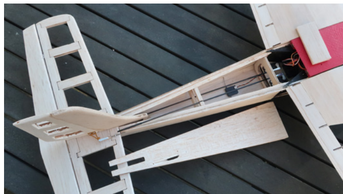
Die Anlenkung verläuft innenliegend und ist den nötigen Kräften entsprechend dimensioniert
