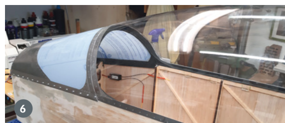
4) Anpassen des Flügels und der Wurzelrippe. Permanente Gewichtskontrolle ist das A und O. 5) Das Glück meinte es gut. Eine Fox-Haube passte beinahe perfekt auf die SubSonex. Hier wird gerade der Rahmen eingepasst. 6) Dünnes, leichtes Alu verleiht der Haube Steifigkeit und eine ansprechende Optik
