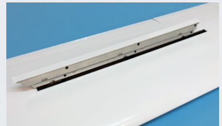
Die Alu-Störklappen sind schon eingebaut, laufen leichtgängig und sind bereits mit einer passgenauen Abdeckung versehen
