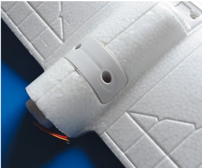
Platz ist im Akkuschacht, jedoch sollte ein weit hinten liegender Schwerpunkt gewählt werden
