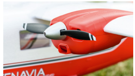
Gegenläufige 8 x 5-Zoll-Propeller sorgen für ausgewogenes und unkritisches Flugverhalten
