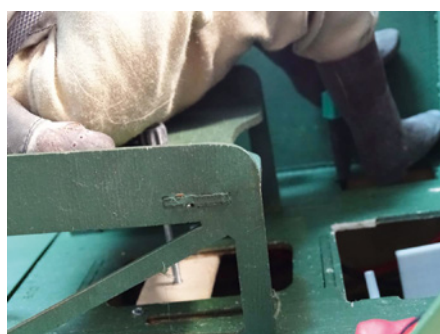
Mit auf Maß geschnittenen Verpackungsgurten und einer Gewinde-Schraube wird der Pilot befestigt
