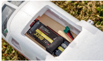
Über die Klappe auf der Rumpfoberseite ist der Akkuraum gut zugänglich. Der dreizellige 3.200er-LiPo ist ideal für das Modell
