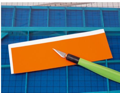
Zum Lösen der nicht zu verwendenden Teile der Selbstklebefolie ist eine spitze Cutterklinge hilfreich. Der Schriftzug wird anschließend vom Träger angehoben und dann einfach auf der Folie befestigt. Zig Ideen lassen sich mit dem Plotter im M1 realisieren
