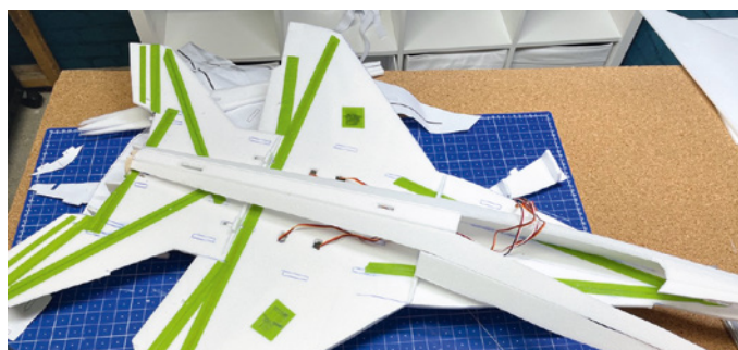
Ein wesentliches Merkmal für die typische Form der MiG ist die Ausgestaltung der Bugsektion. Fünf Versuche mit Prototypen waren erforderlich, bis es halbwegs passte. Entscheidend waren, wie bei den Triebwerksschächten, die zusätzlichen Knicklinien der Seitenwände
