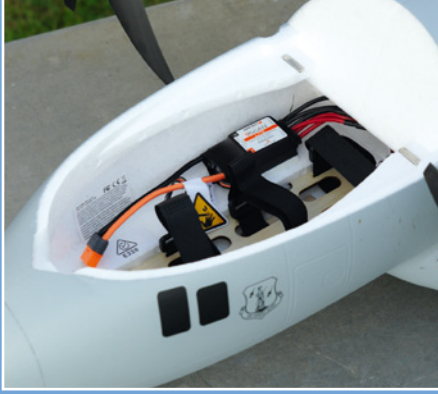
3s- und 4s-LiPos bis 6.400 mAh Kapazität haben Platz im großen Rumpf
