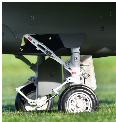
Das Fahrwerkssystem bereitete anfangs ein paar Probleme, die sich aber beheben ließen und seitdem steht die Aermacchi auf schönen, eigenen Füßen
