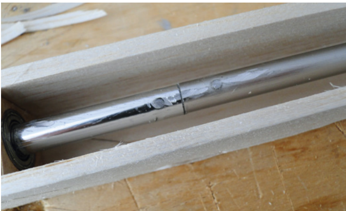
Da sich keine maßhaltige Welle über 1.000 mm Länge finden ließ, wurden zwei davon zusammengefügt
