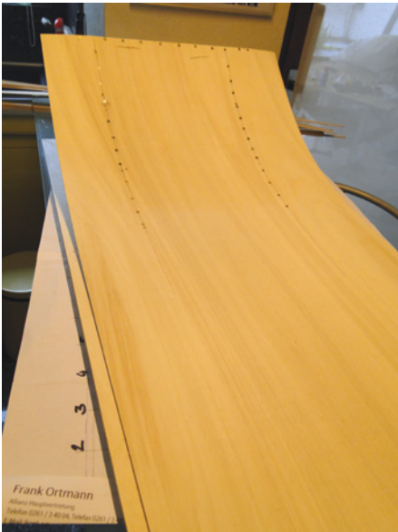
Für den Bau der Flügel wurde eine Helling erstellt. So gesehen besteht das „Baubrett“ aus 4-mm-Pappelsperholz
