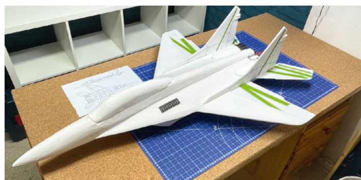
MiG-29 unmittelbar vor dem Erstflug. Die kleinen Dekobleche sollen die charakteristischen Luftenlässe oberhalb der Triebwerkeinlässe imitieren und etwas zusätzliche Kühlung ermöglichen
