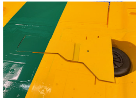
Damit die beiden Deckel sich auf keinen Fall verkleben können, trennt sie ein Stück gelbe Kunststoffolie
