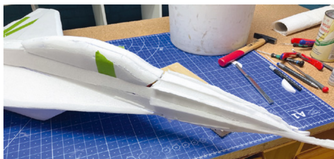
Aufgrund der vielen „Knicklinien“ musste auch viel gespachtelt und kaschiert werden. Für die grobe Vorarbeit wurden Depronreste mit Hilfe von Verdünner, quasi als Spachtelersatz, in die Ritzen gestopft
