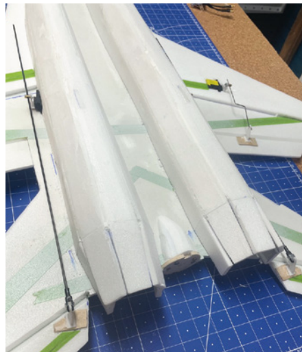
Die Triebwerksdüsen sind im Bauplan noch klassisch aus Depron ausgelegt. Später folgte die Entscheidung, passend zugeschnittene „Turbinenaulässe“ aus dem Modellfachhandel zu nutzen, wie man sie am lackierten Modell erkennt
