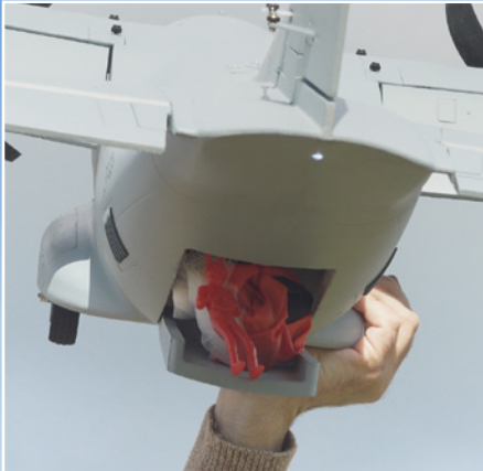
Zum Absetzen des Springers sollte die offene Klappe etwas nach unten neigen
