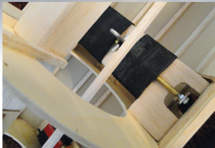
Hier ist das hintere, in Gummi gelagerte Fahrwerkslager zu erkennen
