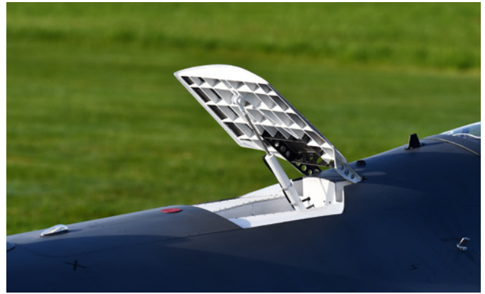
Die Bremsklappe ist mit der Bremsfunktion der Fahrwerke gekoppelt
