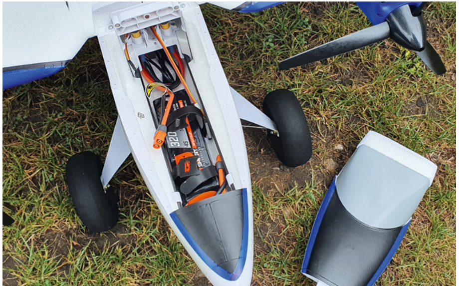
Eine große Klappe macht den Akkuwechsel leicht. Im Testmodell kommt ein 4s-LiPo mit 3.200 mAh Kapazität zum Einsatz
