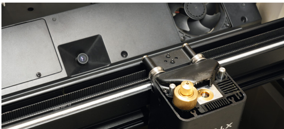
Im Laserkopfgehäuse ist neben dem Laser ein demontierbarer Messerhalter zum Plotten integriert. Außerdem im Bild sind die M1-Innenkamera und der Passivradiator
