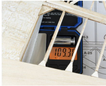
Die Waage lügt nicht – eine rohbaufertige Tragfläche wiegt gerade einmal 109 g
