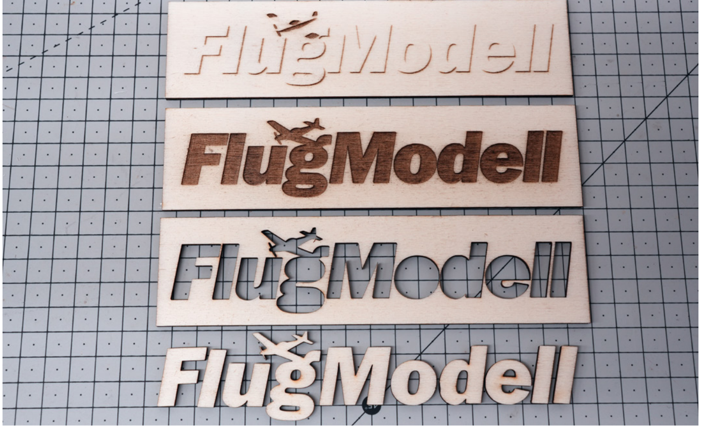
Oben ist das unbearbeitete Bild graviert worden und relativ flau, weil sich weiß nicht gravieren lässt. Das vollflächige schwarze Logo ist leicht zu gravieren und die Buchstaben sind einfach zu lasern
