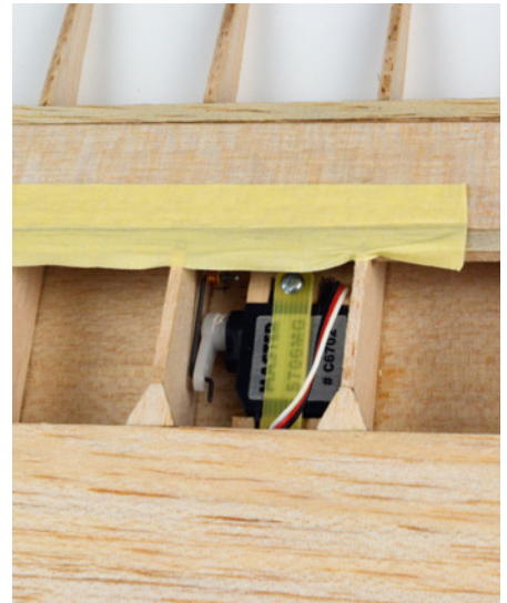
Mit Hilfe eines provisorischen Scharniers werden die Stelldrähte angefertigt und eingestellt
