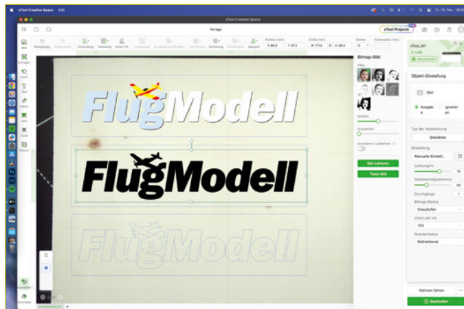
In Creative Space lassen sich Bilder, beispielsweise Logos importieren und so umwandeln, um diese zu gravieren oder deren Konturen zu lasern beziehungsweise zu plotten
