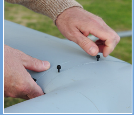
Leicht lösbare Rändelschrauben fixieren die Flügel am Rumpf
