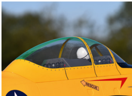
Auf der Cockpitkanzel ist ein klarsichtiger grüner Streifen aufgeklebt worden. Nieten sorgen für mehr Authentizität
