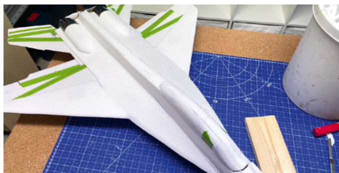
Die Oberseite ist nahezu komplett und muss nur noch verschliffen und stellenweise gespachtelt werden. Im Bereich der Triebwerksauslässe erkennt man bereits die Fertigteile aus Kunststoff und die dafür notwendigen Attrappen
