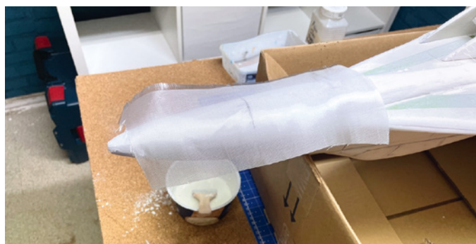
Glasfasermatte in Kombination mit dem obligatorischen Parkettlack schützt zwar nicht vor Schmutz, beugt aber ernsthaften Beschädigungen beim Landen beziehungsweise bei Bodenberührung vor
