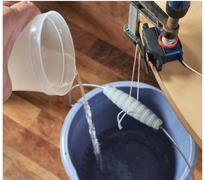
Abbildung 1: Servotest mit einem Wassereimer; der schwebt knapp über dem Boden. Man füllt so viel Wasser ein, bis das erforderliche Drehmoment erreicht ist. Das Servo sollte die Masse halten und sich anschließend noch bewegen können
