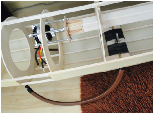
So sieht's mit Antrieb und Welle im Rumpf aus. Auch die Gummidämpfung des Fahrwerks aus Fahrradschlauch ist noch gut zu erkennen
