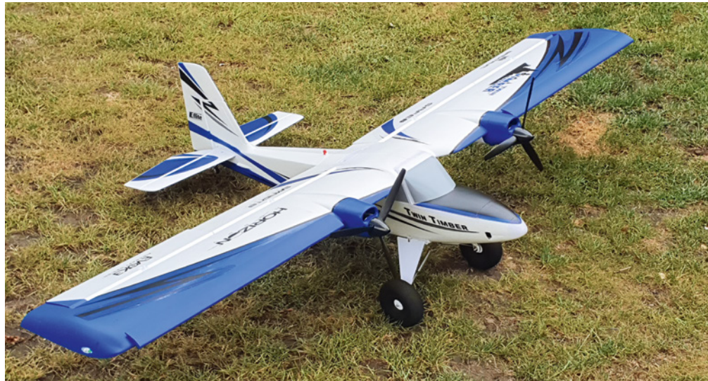
Große Spannweite sowie Flächentiefe sorgen für gute und Landeklappen sowie Vorflügel für sehr gute Flugeigenschaften
