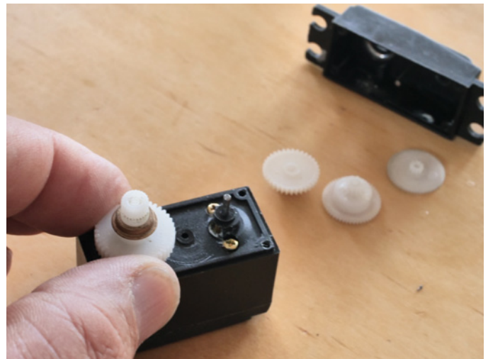
Abbildung 6: Entnimmt man bei einem Servo das Getriebe, lässt sich testen, ob es sich um ein P- oder PI-geregeltes System handelt
