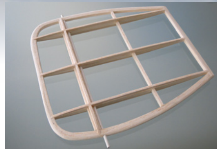
Das Pendel-Seitenruder ist eine leichte Konstruktion aus laminierten Balsaleisten
