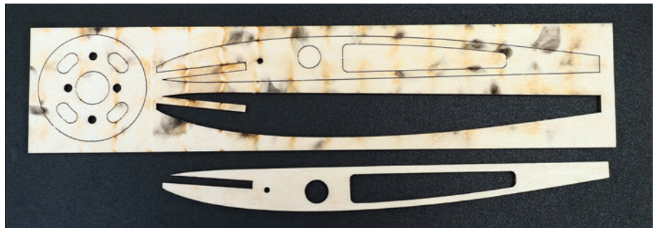
An einigen Stellen ergab sich Abbrand durch den Laser. Bei transparenter Bespannung sollte man sichtbare Teile zuvor vorsichtig behandeln
