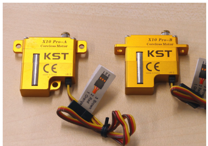
Links das KST X10 Pro-A für die Liegendmontage und rechts das Pro-B für die stehende Montage. Die Neuen sind nicht nur kompakter, sondern auch etwas stärker und haben den Kabelausgang jetzt am Gehäuseboden, was gerade bei der Stehendmontage in engen Schächten Vorteile bringt
