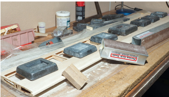
Die Nasenleiste besteht aus einem Balsavierkant, der anschließend in Form zu schleifen ist; lange Schleiflatten sind dabei besonders hilfreich und vermeiden wellenförmige Schleifergebnisse
