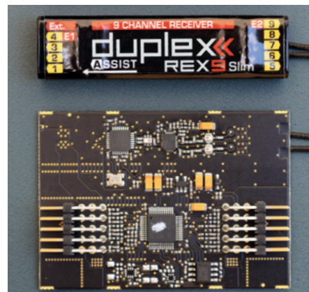
Das Bild zeigt den Aufbau des Empfängers. Die Platine wird im flachen Zustand bestückt und danach in ihre Kastenform gebracht. Ein Aufkleber sorgt später für die passende Beschriftung
