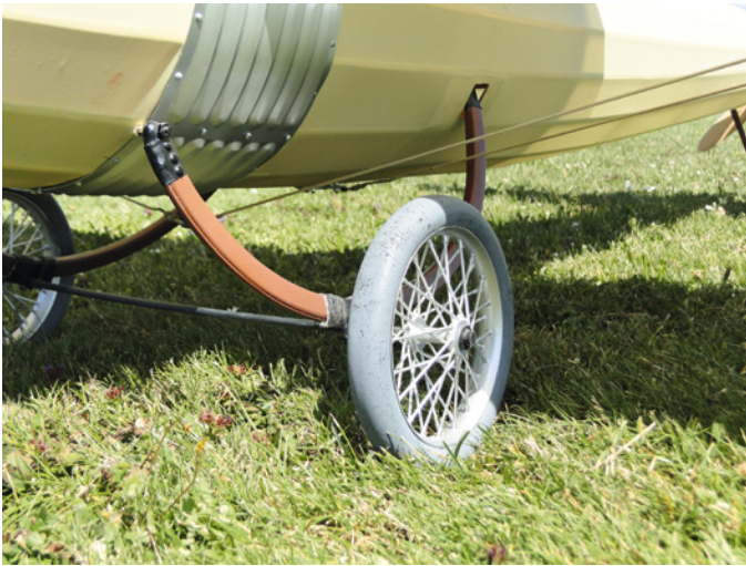
So sieht das Fahrwerk komplett aus, vorne ist es drehbar gelagert, hinten schwenkt es in den Rumpf ein. Die Kiemenbleche gab es als Fertigteile bei Zeller-Modellbau
