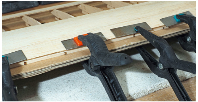
Um das Befestigen der oberen Beplankung aus Balsabrettchen zu erleichtern, sollte man diese zuvor leicht befeuchten. Die sich hier ergebende D-Box versteift den Flügel optimal
