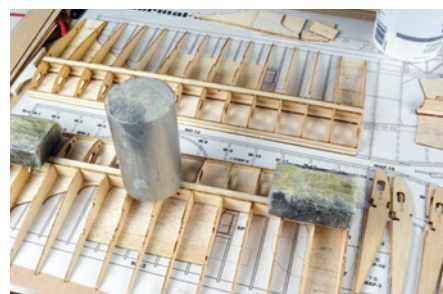
Zum Hochziehen der vorderen, unteren Beplankung mit Hilfe einer Unterlegleiste wird die Tragfläche auf das Baubrett gedrückt
