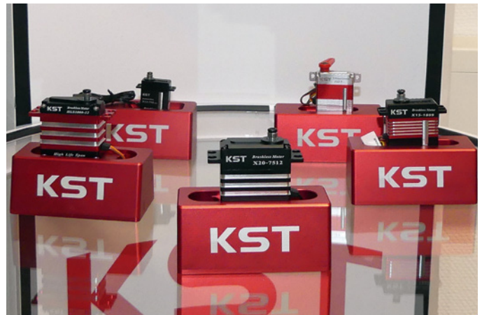
Eine kleine Auswahl aus dem Portfolio. Das Hochvolt-Servo KST X20-7512 V8.0 vorne hat bei 8,4 V ein Drehmoment von beeindruckenden 82 kg.cm
