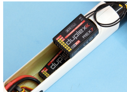
Einbausituation im F3F-Modell Orden. Der Rex 7 ist schlichtweg zu breit, aber der Slim-Empfänger findet im schlanken Rumpf optimal Platz
