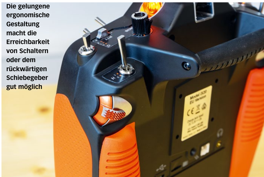
Dank Touch-Switching braucht man einen der berührungsempfindlichen Schalter nur antippen, dann erfolgt per Sprachansage die Nennung der Funktion/Schalterstellung
