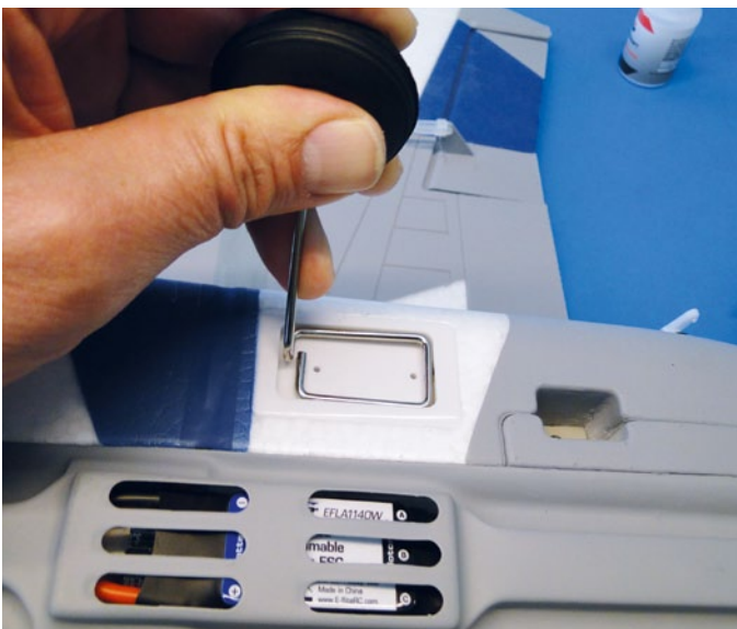
Das optionale Fahrwerk ist mit wenigen Handgriffen am Modell befestigt
