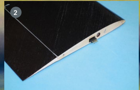
1) Hier muss nichts eingeklipst werden. Als Besonderheit besitzt das Höhenleitwerk kein Ruderhorn im üblichen Sinne. Ein 1,2-mm-Stahlstift greift im Rumpf in ein passendes Röhrchen, das wiederum am Anlenkungsdraht befestigt ist. 2) Die Flügelsteckung ist mitsamt der Servostecker ebenso betriebsfertig aufgebaut wie das restliche Modell
