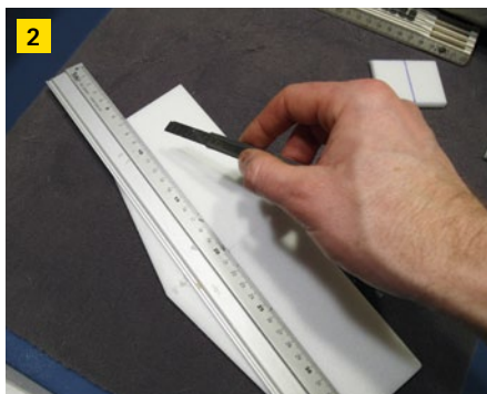
1. Spinnaker-Reparatur-Tape ist ideal als Scharnierband für Depronmodelle geeignet 2. Das Höhenruder wird mit einem schrägen Schnitt abgetrennt; so kann man es ohne weitere Bearbeitung umgedreht mit Scharnierband befestigen 3. Sieht absurd aus, aber diesen Ausschlag kann man beim TrottelDecker tatsächlich gebrauchen
