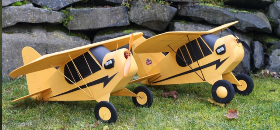
Beide Piper Chubs auf einen Blick: Links die Variante ohne V-Form, die leichter ist als ihre große Schwester mit V in der Tragfläche. So sehen sie aus: die vorbildgetreuen Chubs
