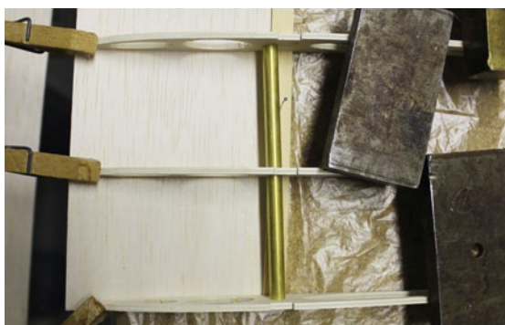
Die Steckungsrohre sind schräg nach hinten eingebaut. Dadurch ergibt sich eine korrekte Pfeilung und V-Form
