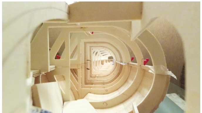
Der Blick in den Rumpf offenbart noch einmal die Bauweise in zwei Hälften. Sie gestattete erst den verzugsfreien Aufbau
