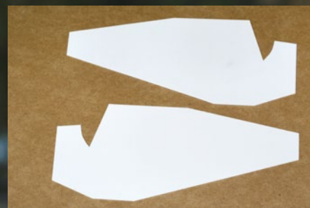
Die Teile für den Rumpf bestehen aus 3-mm-Depron
