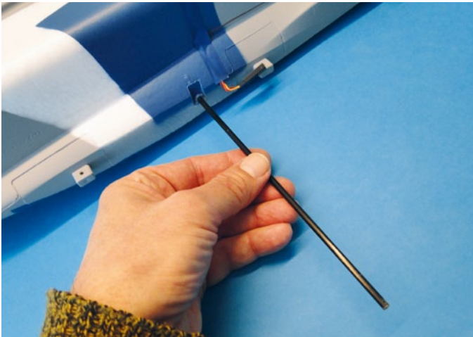
Ein Kohlefaser-Rohr dient als Holmbrücke für die ansteckbaren Flügel
