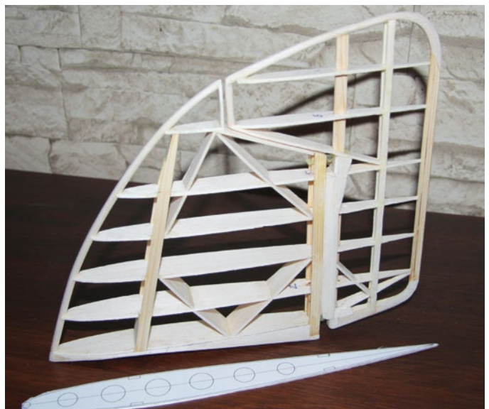
Eins von drei Seitenleitwerken. Bereits beim Bauen wurde eine Kehllagerung berücksichtigt
