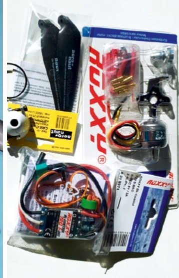
Links der noch im Testmodell verbaute, sehr gute Brushless-Antrieb mit 2.200 kv und 8 x 6-Zoll-Klapppropeller. Rechts im Bild die ganz aktuell verwendete Antriebs-Combo bestehend aus Motor roxy C28-27-26 930 kv, Regler roxy BL-control 720 SBEC und aero-naut 10 x 6-Zoll-Prop. Diese soll noch optimalere Flugleistungen erlauben
