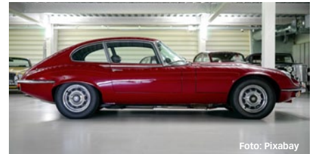
Abbildung 4: der Jaguar E-Typ hatte einen sehr geringen Widerstand wegen seines spitz zulaufenden Hecks
