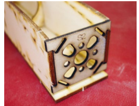
Die gelaserten Trennlinien an der Motorgondel
