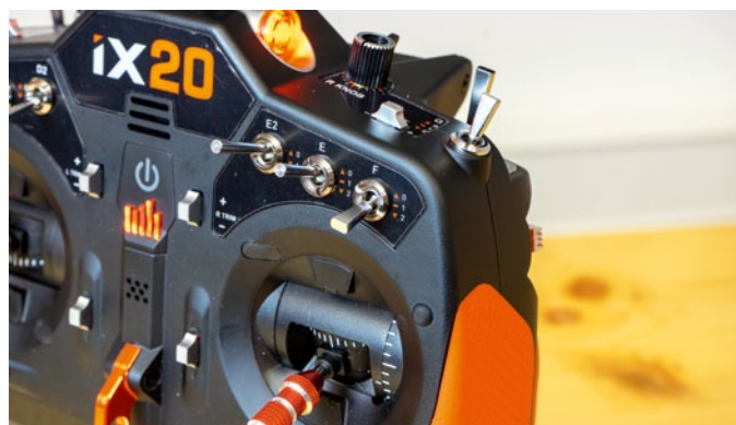
Dank Touch-Switching braucht man einen der berührungsempfindlichen Schalter nur antippen, dann erfolgt per Sprachansage die Nennung der Funktion/Schalterstellung
