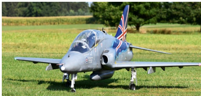
Markant an der BAE Hawk sind die Rumpfform, die relativ kleinen Luftenlassöffnungen und die in negativer V-Form angebrachten Pendelhöhenruder
