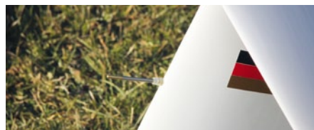
Ein Stück Silikonschlauch hält die Sonde jeweils im ein- oder ausgefahrenen Zustand
