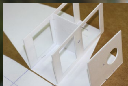
Mit kleinen Stecknadeln werden die einzelnen Teile des Rumpfs während des Zusammenbaus gehalten
