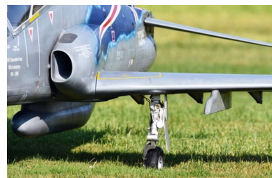
Die Fahrwerkskulisse wurde durch einige Scale-Anbauteile verfeinert
