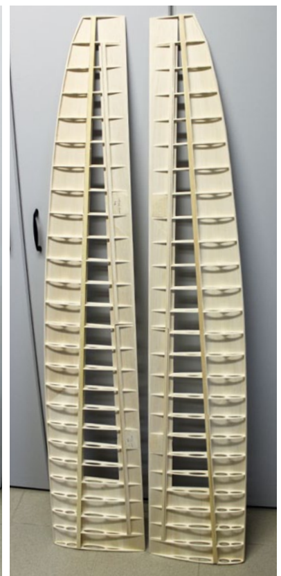
Das fertige Flügelgerippe. Die Flügellänge beträgt 1.453 mm
