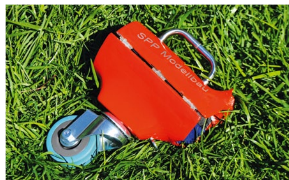
Auf der anderen Seite sorgen klassische Scharniere dafür, dass sich der Kuller weit öffnen lässt. Das Rad ist gut zu befestigen
