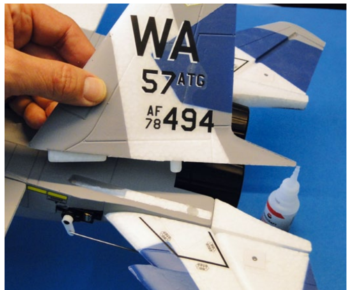
Die Leitwerke habe ich mit normalem, mittelviskosem Sekundenkleber eingesetzt
