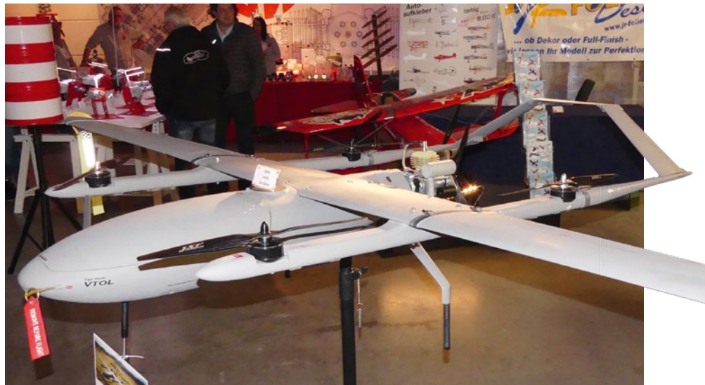
Die Tiger Shark mit 3.500 mm Spannweite kann beim Einschalten des 3W-Motors bis zu 5 Stunden fliegen
