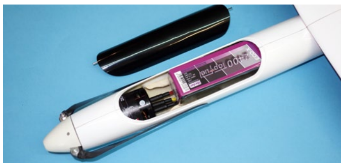
Mit eingesetztem Antriebsakku wird es vorne voll im Rumpf. Doch es hat alles seinen Platz und es ist kein Trimmblei notwendig
