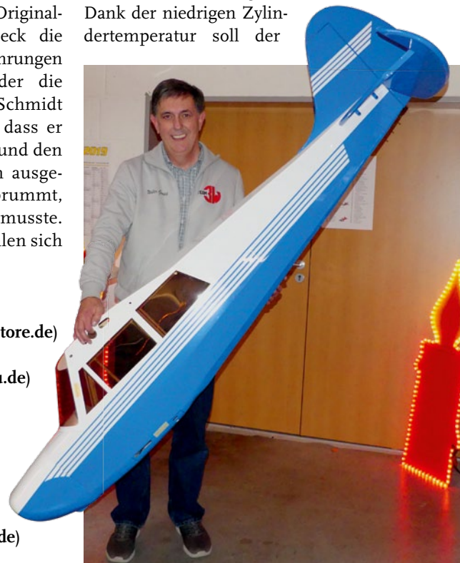
Die Husky von Grupp hat eine Spannweite von 3.600 mm, eine Länge von 2.320 mm, wiegt bis 15 kg und kostet 1.395,- Euro
