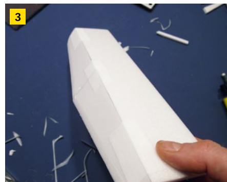
1. Spinnaker-Reparatur-Tape ist ideal als Scharnierband für Depronmodelle geeignet 2. Das Höhenruder wird mit einem schrägen Schnitt abgetrennt; so kann man es ohne weitere Bearbeitung umgedreht mit Scharnierband befestigen 3. Sieht absurd aus, aber diesen Ausschlag kann man beim TrottelDecker tatsächlich gebrauchen
