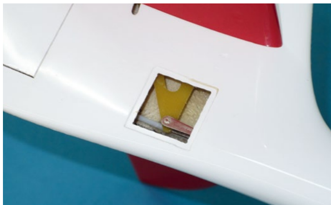
Um an den Pendelhöhenruderhebel zu gelangen, gibt es auf der rechten Rumpfseite eine Revisionsöffnung
