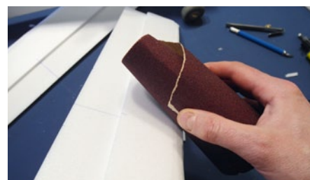
Im zweiten Schritt kann man dann mit Hilfe einer Schwammnudel und 180er-Schmirlpapier die Kontur herausarbeiten
