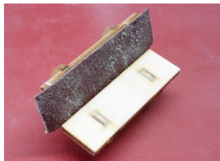
Im Bausatz enthalten ist ein Hilfsmittel, das das Schleifen der V-Kehle an den Querrudern erheblich vereinfacht
