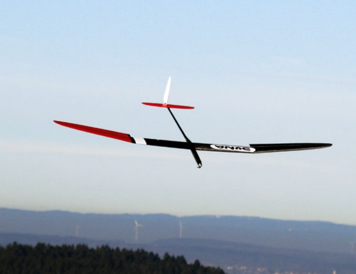
Das niedrige Abfluggewicht in Verbindung mit der Butterfly-Stellung lässt sehr steile Landeanflüge zu
