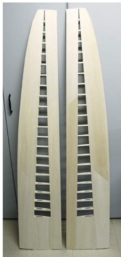
Das fertige Flügelgerippe. Die Flügellänge beträgt 1.453 mm
