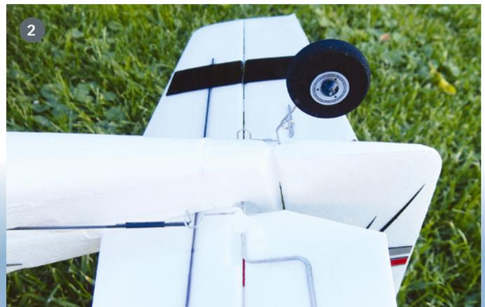
1.) Sehr robust ist das Fahrwerk ausgeführt. Die Kunststoffstütze schützt den Schaum bei sehr harten Landungen ganz hervorragend. 2.) Die UMX Turbo Timber startet auch aus hohem Gras und ist dank des großen Spornrads dabei sogar steuerbar. 3.) In der Luft macht die UMX Turbo Timber eine tolle Figur. Beinahe extrem ist der Motorsturz
