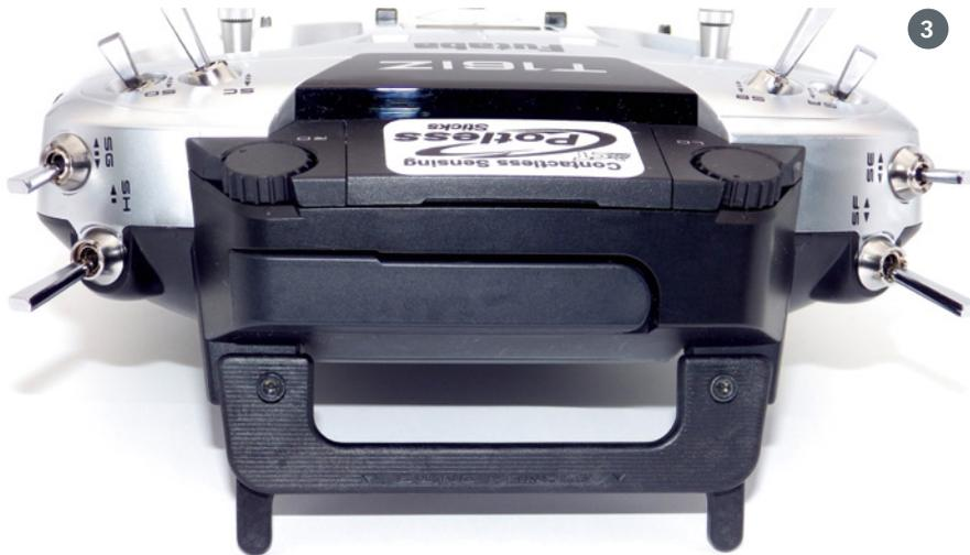
1.) Über das berührungsempfindliche, 4,3 Zoll große Farbdisplay erfolgt die Programmierung mit Fingereingabe und Bestätigungstasten 2.) Zwei Drehgeber sind frontseitig platziert, rückseitig befinden sich zwei gut erreichbare Schieber 3.) Das integrierte Klick-Pult ist ebenfalls eine ACT-Spezialität ebenso wie eine optionale Senderakkuweiche
