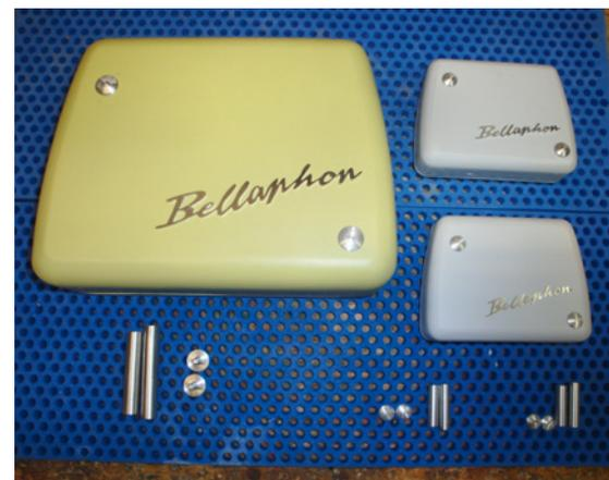
Da sich das 3D-Objekt am Computer skalieren lässt, entstanden 3D-gedruckte Gehäuse in 1:1 und 1:2
