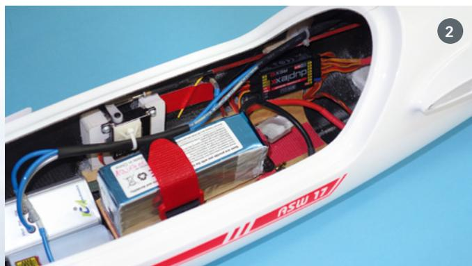
1.) Vorne im Rumpf sitzt natürlich der Motor, dahinter der GPS-Empfänger und das GPS-Triangle-Telemetriesystem Raven. Daneben der 2s-Lilon-Backup-Empfängerakku. 2.) Neben dem Antriebsakku kommen die Rumpfservos zu liegen, dahinter der Empfänger an der Rumpfsseitenwand und unterhalb der Flügelsteckung dann die Aufnahme für das Ballastsystem
