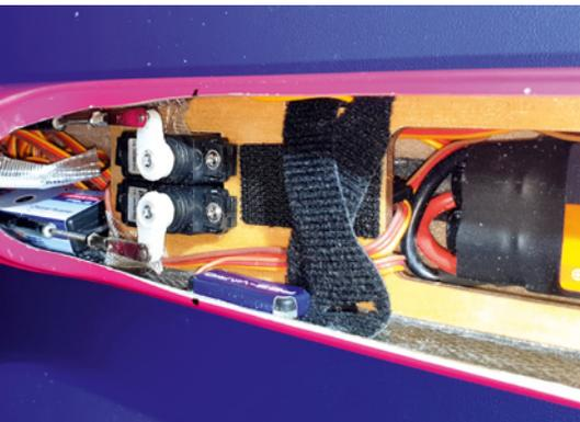
Der Regler sitzt im durchgehenden Lüftungskanal unter dem Montagebrett. Hinter dem linken Servo ist der Core-Empfänger PBS-7S positioniert, dessen Antenne auf das Rumpfdach führt
