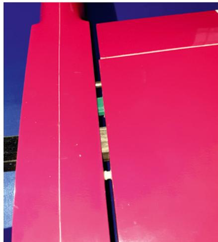
Auf dem Foto ist die Trenn-Naht am Rumpf deutlicher zu sehen, als beim realen Produkt. Nach dem Aufstecken der Flügel auf die Kohle-Brücke muss nur noch der Verriegelungs-widerstand der weißen MultiLocks überwunden werden
