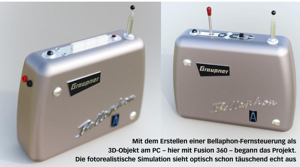
Mit dem Erstellen einer Bellaphon-Fernsteuerung als 3D-Objekt am PC – hier mit Fusion 360 – begann das Projekt. Die fotorealistische Simulation sieht optisch schon täuschend echt aus
