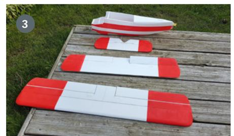
1.+2.+3.) Beim Lackieren kann man es sich auch leicht machen. Maskierband, Acrylfarbe aus der Tube und ein Vliesstreicher sind geeignetes Material für das Finish. Der Effekt ist jedenfalls großartig
