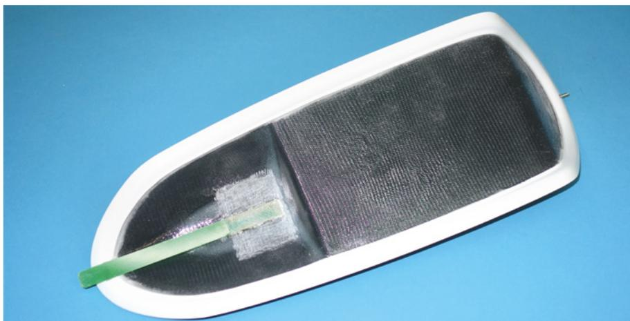
Die Kabinenhaube wird hinten über einen Stift am Rumpf fixiert. Vorne kommt eine GFK-Federzunge zum Einsatz, die von innen am Instrumentenpilz verklebt wird
