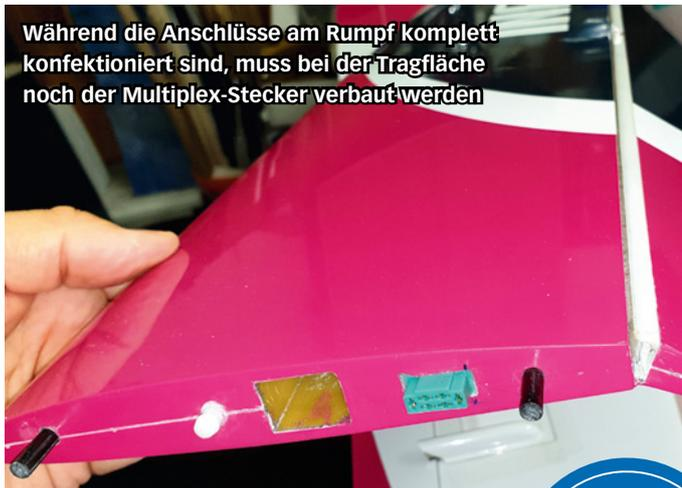
Während die Anschlüsse am Rumpf komplett konfektioniert sind, muss bei der Tragfläche noch der Multiplex-Stecker verbaut werden
