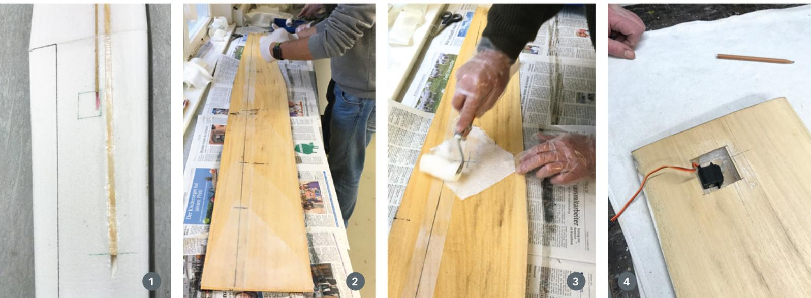
1.) Mit Hilfe des Schneidbügels entstehen auch die Kabelschächte. Hierin liegen lange Strohhalme. Eine Holzleiste sichert alles. 2.) Aufbereiten der aus mehreren Abachiplatten zusammengesetzten Flächenbeplankung mit GFK-Gewebestücken. Markierungen zeigen die Lage von Holm oder Servoschacht an. 3. und 4.) Im Bereich der Servoschächte verstärken GFK-Gewebeauflagen den Bereich, damit die Rudermaschinen später eine stabile Auflage haben
