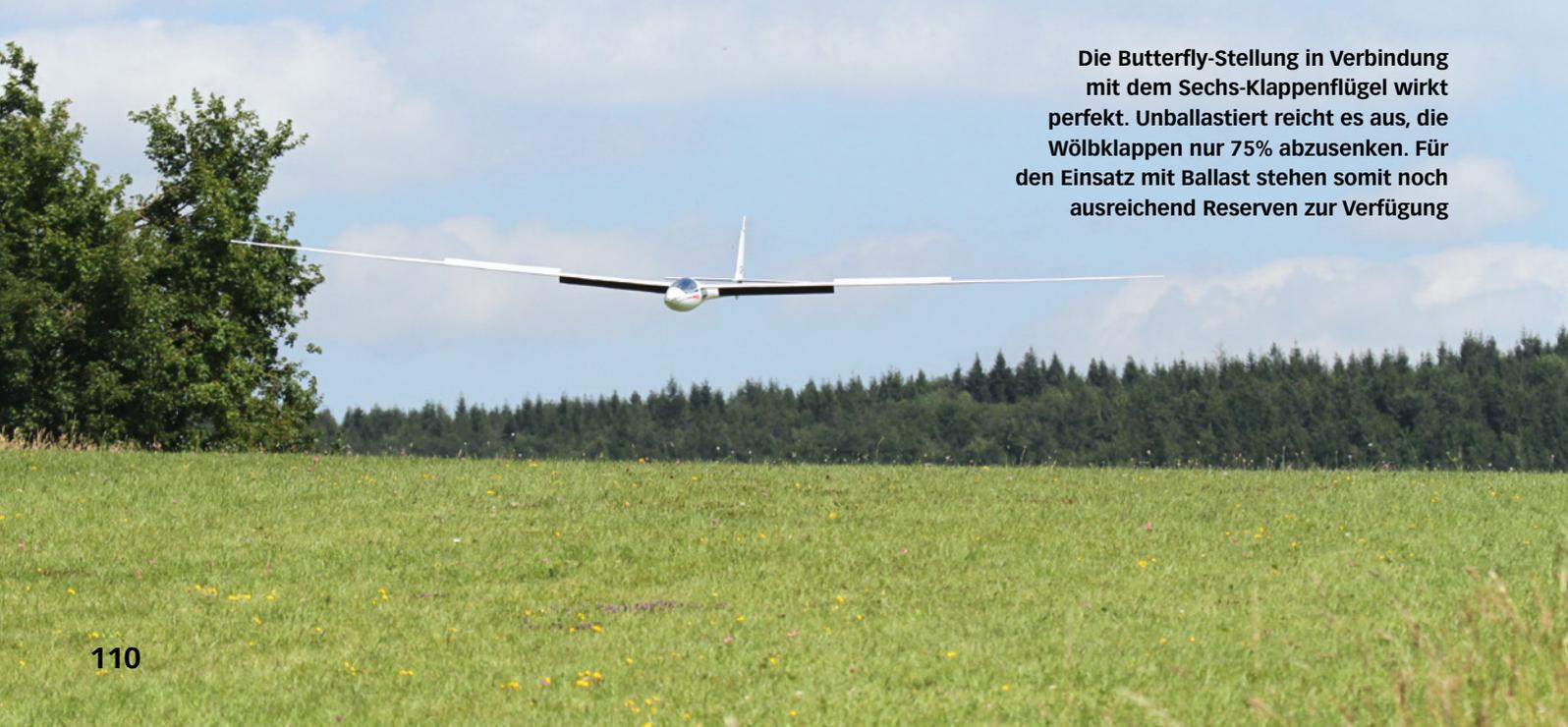
Die Butterfly-Stellung in Verbindung mit dem Sechs-Klappenflügel wirkt perfekt. Unballastiert reicht es aus, die Wölbklappen nur 75% abzusenken. Für den Einsatz mit Ballast stehen somit noch ausreichend Reserven zur Verfügung
