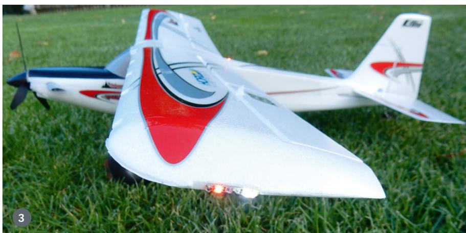
1.) Die große Haube fasst auch einen großen Akku. Selbst ein 2s-LiPo mit 430-mAh-Zellen passt rein. 2.) Die Landescheinwerfer verstecken sich hinter dem Dreiblatt-Propeller, sind aber sehr gut in der Dämmerung zu erkennen. 3.) Eine sehr gute Erkennbarkeit beziehungsweise hohe Leuchtkraft kann man auch den anderen Navigationslichter bescheinigen
