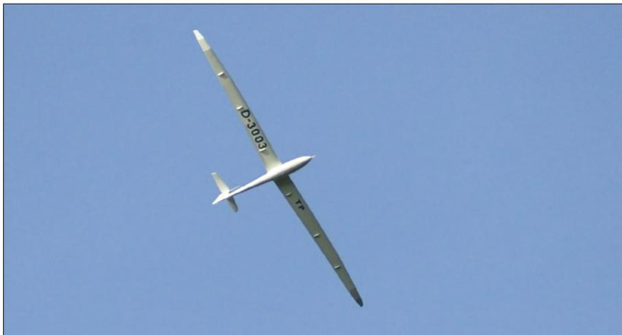
Abbildung 5: Der Ventus 2c kann bezüglich Gleitzahl nicht mit seinem Vorbild konkurrieren, doch seine geringe Sinkrate ist deutlich kleiner als beim Original
