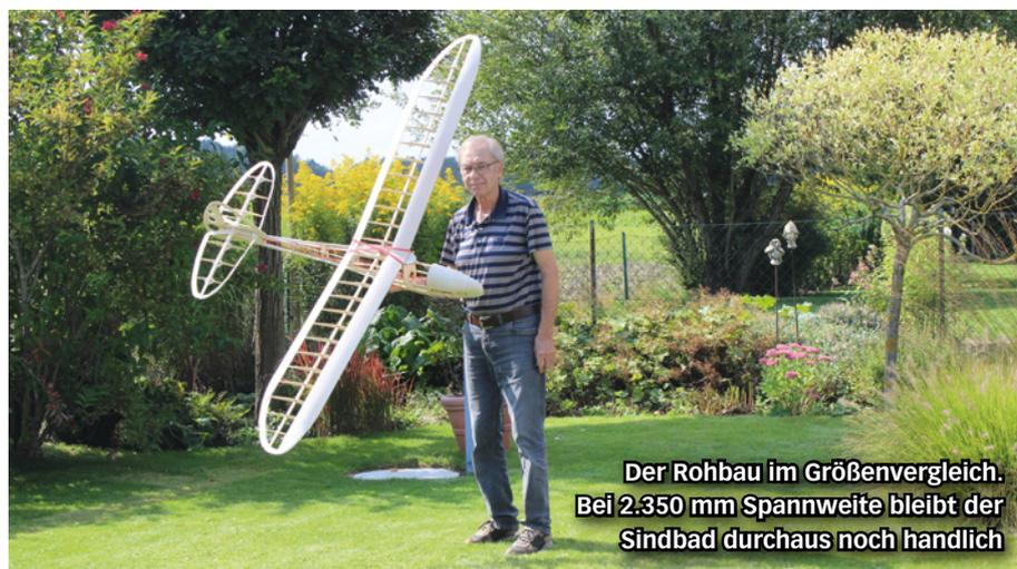
Der Rohbau im Größenvergleich. Bei 2.350 mm Spannweite bleibt der Sindbad durchaus noch handlich
