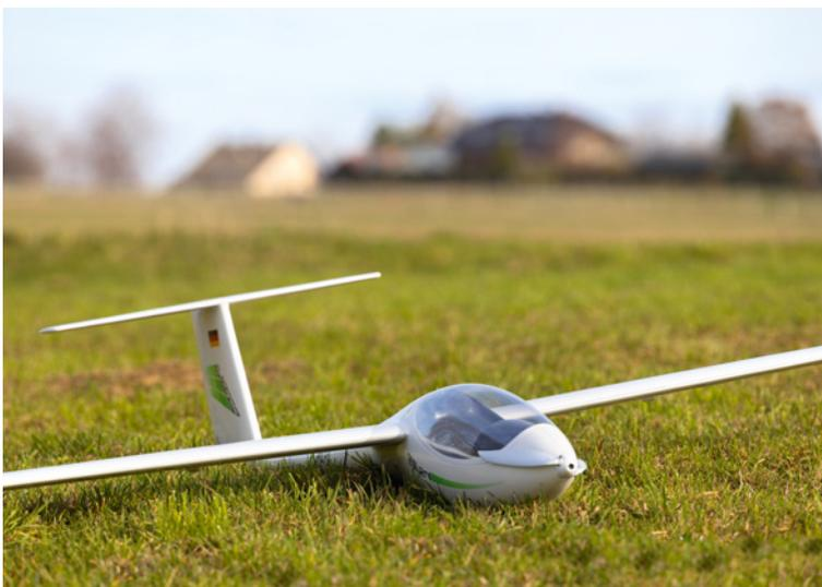
Neu im Scale-Programm ist die 4.000 mm spannende ASW-27 im Maßstab 1:3,75
