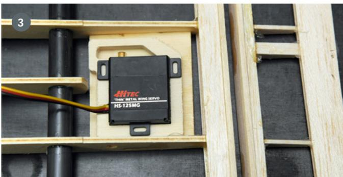
1) Für die Randbögen an den Flächen sind dank vorgefertigter Frästeile nur geringe Anpassungen erforderlich. 2) Unzählige Kleinteile liegen dem Bausatz bei, sind alle hochwertig gemacht und darum gut zu verwenden. 3) Einbau eines Flächenservos. Bewährt und passend sind HS-125MG
