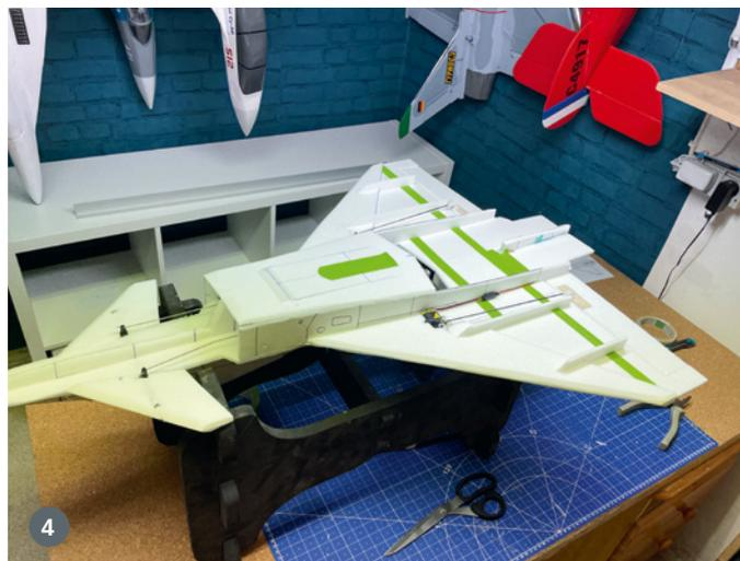
3) Mit den angelenkten Canards ist der Eurofighter bereit für den Erstflug – noch unlackiert, denn Farbe muss sich das Modell erst verdienen. 4) Blick von unten auf die Canards. Die Servos sind geschützt im Triebwerkseinlauf angebracht. Zur Anlenkung musste ich Federstahldraht verwenden, um ein paar Biegungen in den Draht einarbeiten zu können
