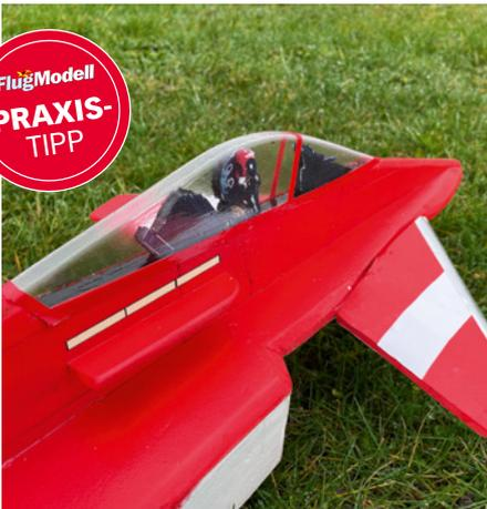
Mit Hilfe einer Tiefziehform, dem heimischen Backofen und Vivak-Kunststoffplatten entstand ein stilisiertes Cockpit, welches bei Silhouetten-Modellen so gut wie nie vorzufinden, bei mir aber inzwischen Standard geworden ist. Der Pilot besteht übrigens aus einer Lage Depron mit beidseitig beklebtem Fotopapier
