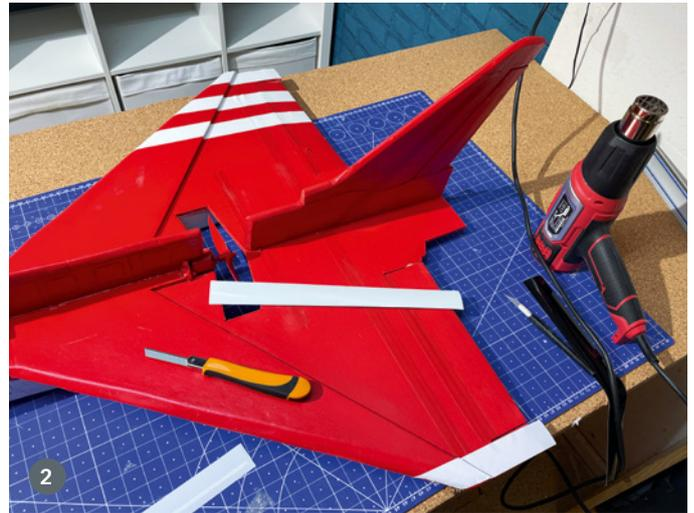
1) Für die Unterseite wird lösungsmittelfreie weiße Sprühfarbe aus dem Baumarkt verwendet. Zum Schutz vor Farbnebel wurden die Ränder abgeklebt. 2) Um die Fluglage in der Luft zu erkennen, wurden weiße Blockstreifen aus Folie verklebt
