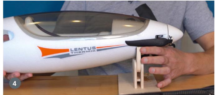
1) Zapfen und Nuten sorgen für einen sicheren und zweifelsfreien Zusammenbau. 2) Die Bananen-förmig aussehenden Wippen lagern drehend über Stahlstifte in den Halterungen. 3) Rechteckige Rumpfe neigen selten zum Kippen, aber mit dem Halter ist eine rutschsichere Klemmung garantiert. 4) Große Rumpfe lassen sich durchaus fixieren. Dank der Gummiauflage eignen sich die Halter auch für Schaummodelle
