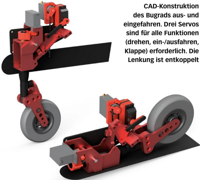
CAD-Konstruktion des Bugrads aus- und eingefahren. Drei Servos sind für alle Funktionen (drehen, ein-/ausfahren, Klappe) erforderlich. Die Lenkung ist entkoppelt
