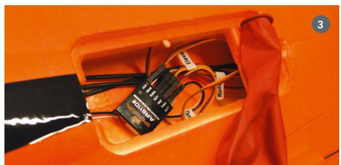
1) Der Drehzahlsteller ist ab Werk für den Wasserflugeinsatz versiegelt. 2) An den Ruderhörnern sorgen Metall-Verbinder mit Inbusschrauben für eine gut justierbare und spielfreie Anlenkung. 3) Der Empfänger findet in einem separaten Elektronikfach seinen Platz. Der mitgelieferte Luftballon soll ihn wasserdicht machen. Sicherer ist jedoch Wet-Protect-Spray
