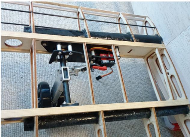
Einbau des Hauptfahrwerks für erste Probeläufe – auch dieses entstand zunächst am PC
