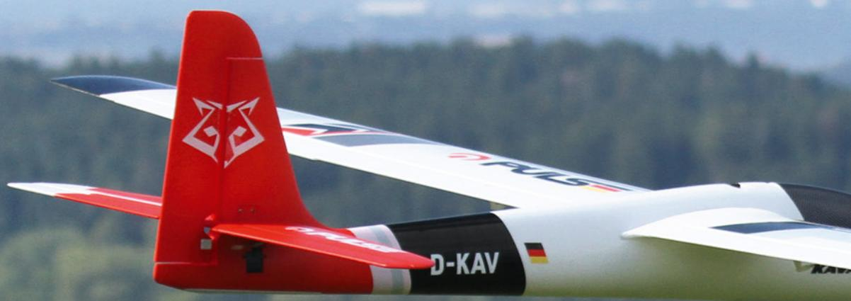
**M**it 2.200 mm Spannweite ist der Pulse 2200 von Kavan – unser Testmuster ist bei Bay-tec.de erworben worden – dank geteilter Tragflächen kompakt und trotzdem nicht zu klein geraten. Ein stabiler Vierklappenflügel sorgt für Agilität, der Rumpf erinnert insbesondere im hinteren Bereich an einen in Modellbauerkreisen recht bekannten Kunstflugsegler. Dass bei der Entwicklung des Pulse der Fokus auf Hang- und Kunstflug gelegt wurde, zeigt ebenfalls die fehlende V-Form.
