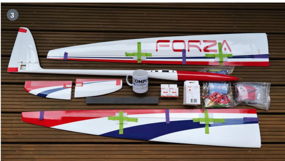
1) Oben zu sehen das CFK-Ballastrohr, darunter fünf passende Messing-Ballast-Teile und die beiden Messing-Stangen zur Ballastierung der Flächen. 2) Zu den KST-Servos liefert Composite RC Gliders passende Servorahmen mit, die die Montage wesentlich vereinfachen. 3) Bei Composite RC Gliders wurde auch gleich das Servoset zum Modell geordert
