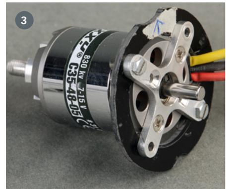
1) In die Heckflosse sind Bohrungen und Pendelslitze eingefräst. 2) In der Heckflosse sitzt der Umlenkhebel zum Betätigen des Pendel-Höhenruders. 3) Ein Brushless-Motor vom Typ Roxy C35-48-05 sorgt für ausreichend Schub. Die Rückwandmontage erforderte eine etwas unorthodoxe Befestigung am Motorspant
