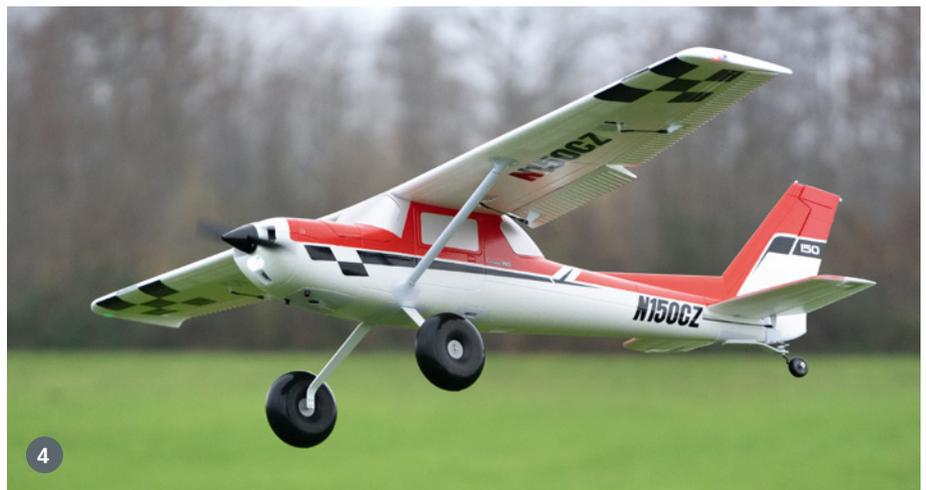
1) Im Rückenflug muss man schon mit Tiefe halten, aber die Motorpower und Auslegung der modernisierten Cessna machen solche Manöver mit. 2) Kraftvolles Steigen, Hoovern, Torqen, diese Cessna ist auch dafür geeignet. 3) Mit Splinten gesicherte Lager halten die Flächenstreben sicher an ihren Platz. 4) Dank Tundra-Bereifung machte Horizon Hobby aus der Grand Dame Cessna 150 eine moderne Lady mit STOL-Qualitäten
