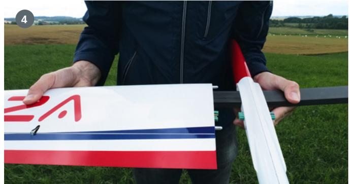
1) Damit die vom MPX-Stecker abgehenden Servokabel nicht mit der Steckung kollidieren, sorgt ein kleines Holzbrett. 2) Zur Sicherung des Messing-Ballasts im Ballastrohr dient eine leicht lösbare Verriegelung. 3) Die durchgehende Steckung für die Mitnahme beider Ruderhälften war durch minimales Abschleifen passend zu machen. 4) Zusammenstecken der Flächen – der massive CFK-Steckverbinder passt saugend und perfekt in Rumpf und Flächen
