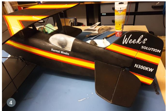
1) Um dem Vorbild näher zu kommen, sind vor dem Lackieren mit Schwarz die farbigen Bereiche abzukleben. 2) Die charakteristischen Streifen werden aus Klebefolie hergestellt. 3) Die Zierstreifen kann man einfach mit Cutter und Lineal schneiden. 4) Mit einem Plotter hergestellte Schriftzüge und ein „Schattenpilot“ komplettieren die Optik
