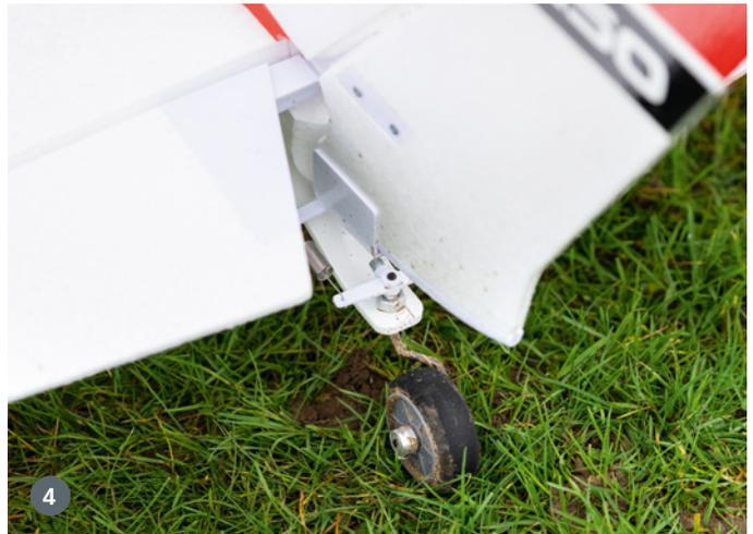
1) Über die abnehmbare Haube ist ein Akkuwechsel schnell erledigt. Praktischerweise lassen sich 4s-, 5s- und 6s-LiPos nutzen. 2) Im Hartschaum integrierte Details und LEDs sorgen für einen authentischen Aiftritt. 3) Beide LED leuchten einem vor allem an trübren Tagen freudig entgegen. 4) Die Tundra-Reifen verleiten zum Fliegen auf weniger geeigneten Pisten und das Spornfahrwerk zieht da klaglos mit
