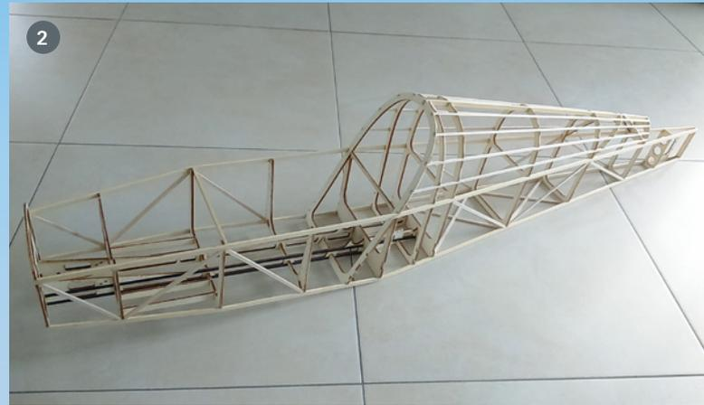
1) Die Konstruktion des gesamten Modells erfolgte zunächst am PC mit dem Programm Fusion360 – dies vermittelte bereits einen authentischen Eindruck. 2) Das komplette Rumpferüst entsteht entsprechend der CAD-Konstruktion aus Holzleisten und Spanten
