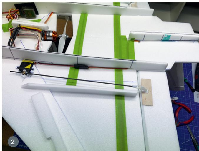
1) Der Zugang zur Elektronik des Eurofighter ist durch eine relativ große Wartungsluke im Rumpfboden gewährleistet. Gleichzeitig dient sie zum bequemen Wechseln des LiPos. 2) Neben den Servos sieht man hier auch die „Raketenaufhängungen“, die sicherstellen, dass der Eurofighter später „wie auf Schienen“ fliegt
