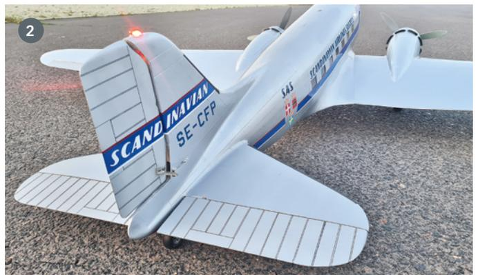
**1) Ein Folienplotter schnitt die verschiedenen Schriftzüge und Zierstreifen auf einer Klebefolie. Einzig die dänischen, norwegischen und schwedischen Landesflaggen entstanden im Digitaldruckverfahren mit lösemittelhaltiger Tinte. 2) Die Andeutung der bespannten Ruderflächen wurde mit Hilfe eines sehr feinen Lumocolor Permanentmarkers erledigt**
