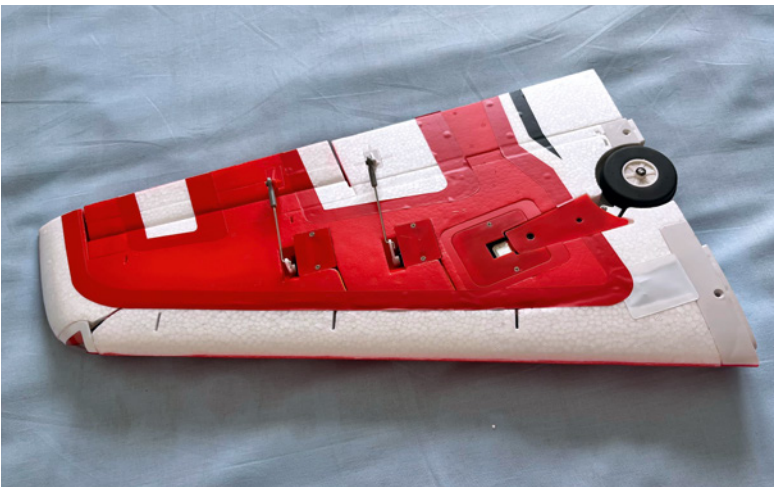
In den Tragflächenhälften sind Servos, Fahrwerk und Beleuchtung betriebsbereit eingebaut. Das Einziehfahrwerk bietet im eingefahrenen Zustand kaum Luftwiderstand
