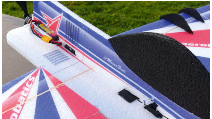
Für Regler und Akku schneidet man selbst die passenden Öffnungen in den Rumpf, die aber so knapp bemessen sein sollten, dass die Teile unter Spannung darin gelagert sind
