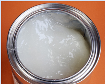
Das Harz HP-E25FB ist bereits gelartig eingestellt. Nach Hinzufügen von Härter steigert sich die Viskosität
