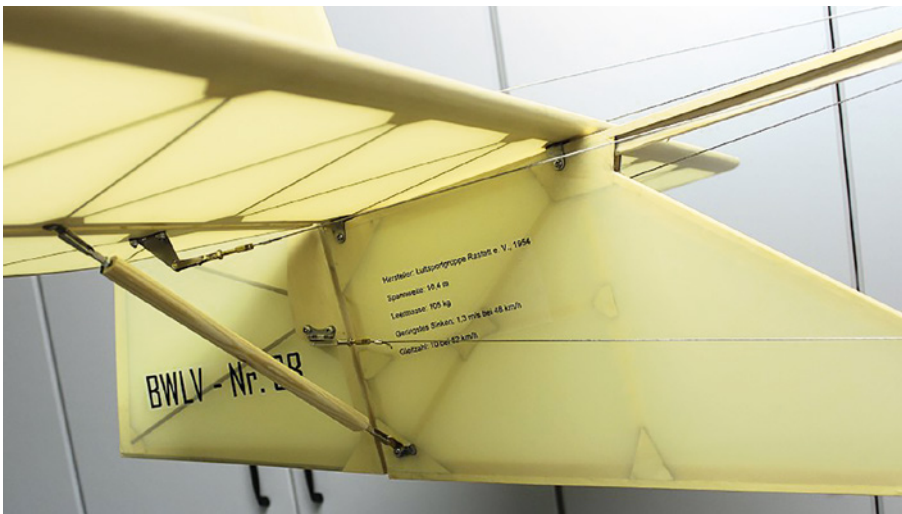
Zwei Streben zum Rumpf wurden anstelle von dünnen Kiefernleisten mit je einer M3-Gewindestange, die mit 15 x 5-mm-Kiefernleisten verkleidet sind, gebaut
