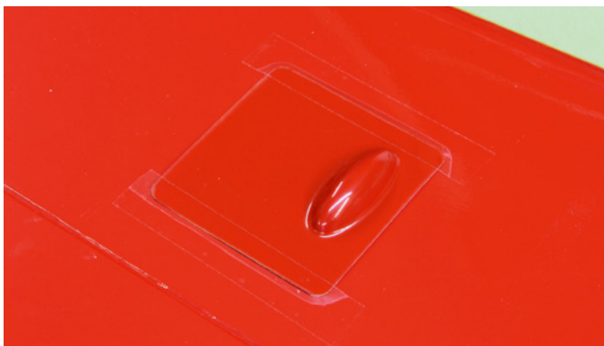
Die Servoabdeckungen sind vorgefräst, passend zur Flächenunterseite eingefärbt und mit Hutzen für die Anlenkungsgestänge versehen
