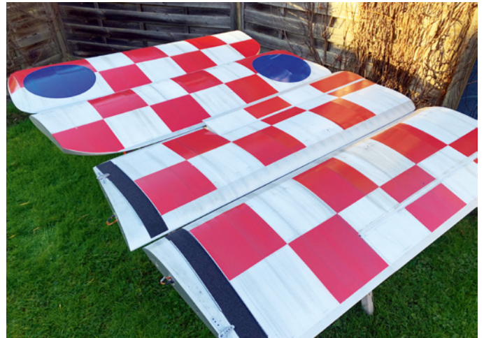
Das Weathering unterstreicht den Used-Charakter. Nach dem Aufbringen der kompletten Kokarde sicherte eine Klarlackschicht die Optik
