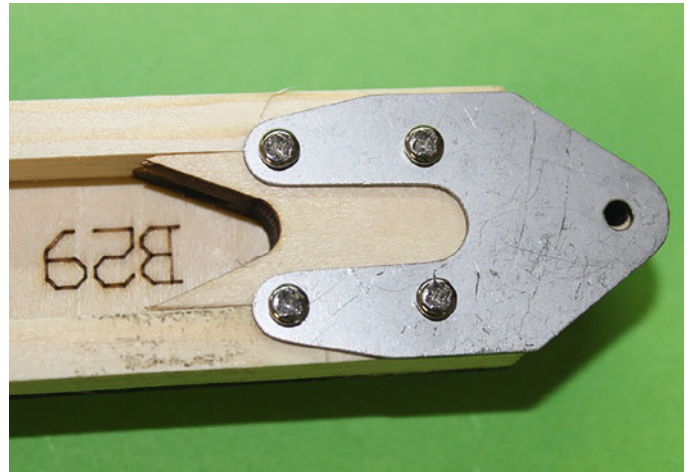
Die Holme an B28 und B29 bestehen aus einer 3-mm-Sperrholz-Verkastung. Die Rippen werden auf die Holme gefädelt
