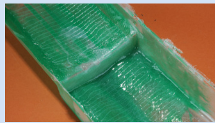
Die Einfärbung hebt Details der Laminierqualität und Struktur hervor
