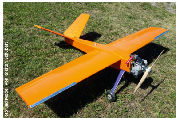
Abbildung 9: Ein typisches Zweck-Schleppmodell mit rechteckiger Flächengeometrie
