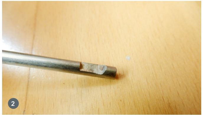
1) Die Bugradanlenkung ist als Erstes zu installieren – hier war jedoch etwas Nachhilfe nötig. 2) Leider passte beim Testmuster die Abflachung des Bugfahrwerksdrahts nicht, wodurch das Fahrwerk klemmte, das ließ sich aber anpassen
