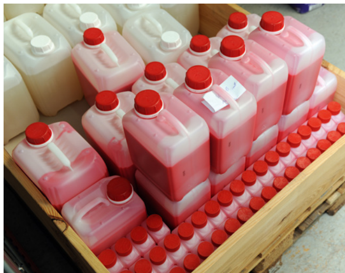
Die hier angefüllte Silikon-Abformmasse wurde vorab in Rot eingefärbt
