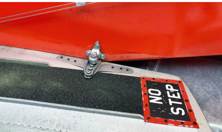
Trittflächen aus Schmirgelpapier steigern die Optik und nachträglich platzierte Halterungen fixieren zusätzlich die Fläche
