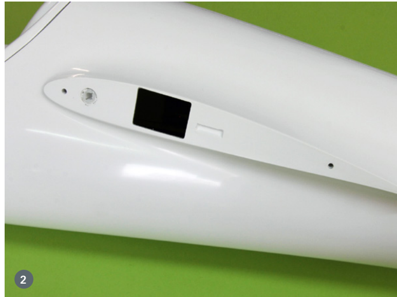
1) Das Zubehör ist vollständig und von sehr guter Qualität, da macht das Bauen doppelt Spaß. 2) Der Rumpf im Auslieferungszustand verfügt über passgenaue Bohrungen für die Torsionsstifte, die Aussparung für den Holmverbinder wurde ausgefräst und die rumpfseitige Flächenbefestigung bereits eingeklebt
