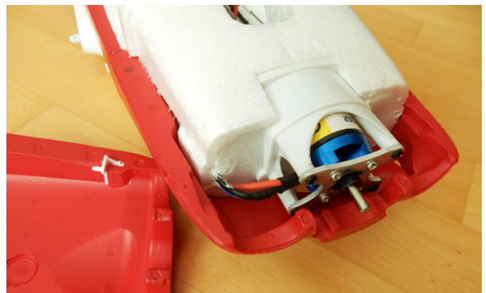
Die abnehmbare Motorhaube gewährt freien Zugang zum Triebwerk und der Anlenkung des Bugfahrwerks
