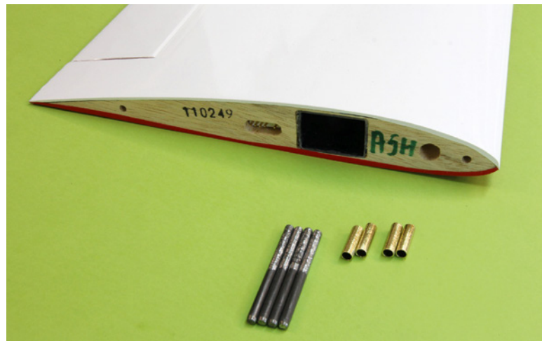
Die Wurzelrippen sind bereit zum Einkleben der Torsionsstifte. Diese sind schon angeraut, für die Rumpfseite liegen die Messingrohrstücke bereit
