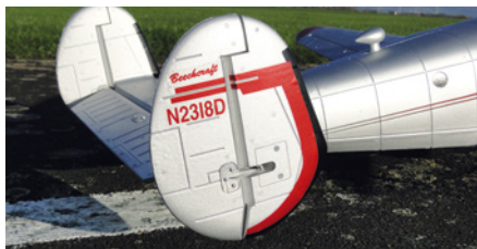
Die Anlenkung der Seitenrudder erfolgt von außen
