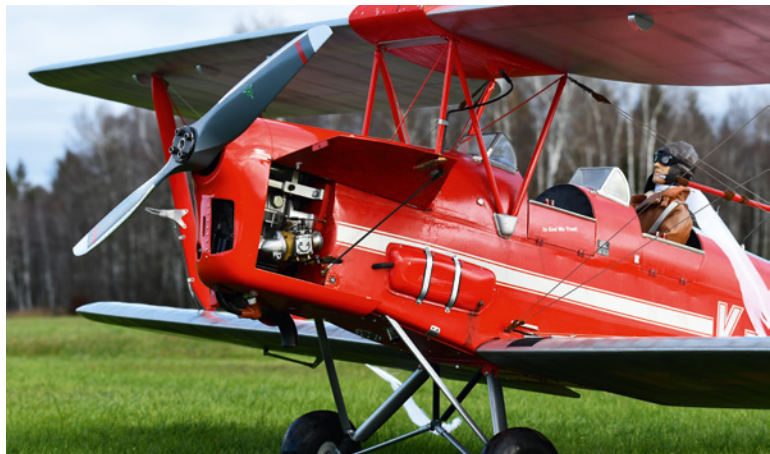
Über die Klappe ist ein einfacher Zugang zum ZG-38 mit seinem Getriebe gegeben. Feineinstellungen beispielsweise am Choke sind dann einfach
