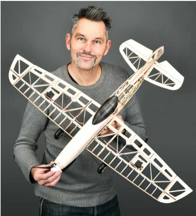
Konstrukteur und unbespannter Wiesel. Hier ist der Rumpfrücken nicht beplankt, was man aber durchaus machen könnte
