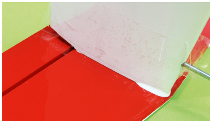
Damit das Höhenleitwerk auch im vorderen Bereich perfekt anliegt, wurde der Rumpf in diesem Bereich mit eingefärbtem Harz versehen und mit montiertem Leitwerk abgedrückt
