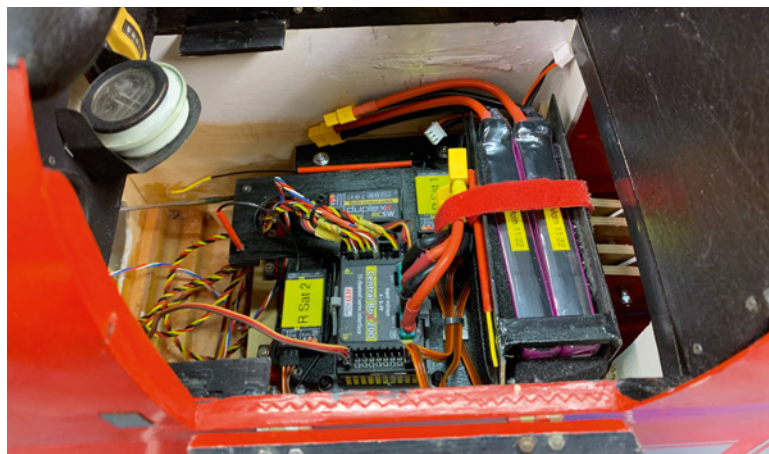
Gut zugänglich unterhalb des Sitzes sind Teile der RC-Elektronik und – optimal im Schwerpunkt – die Akkus zur Stromversorgung platziert
