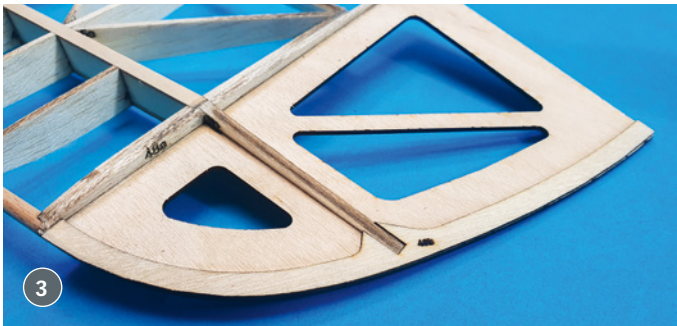
3) Die angenehme Flugstabilität von Wiesel wird auch durch die beiden abgewinkelten Flügelohren unterstützt. Sie bestehen außen aus robustem 1,5-mm-Sperholz, aufgedoppelt mit Nasenleisten-Aufleimern am Randbogen. 4) Die Querruder werden auf direktem Weg angelenkt – die Servos sitzen auf einem angeschraubten Deckel, um jederzeit wieder ranzukommen
