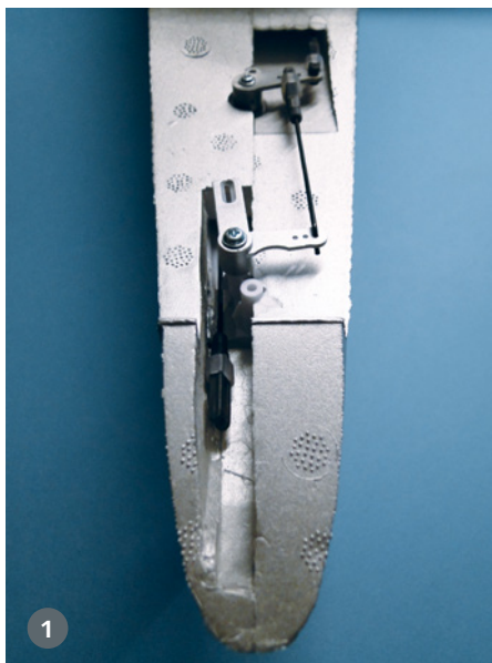
1) Im Rumpffende sorgt eine angelenkte Wippe für die Bewegung der Seitenruder und die Stange mit Gabelkopf bewegt das Höhenruder. 2) Im Höhenleitwerk ist ein verlötetes Gestänge mit Mitnehmer zur Seitenrudersteuerung eingesetzt
