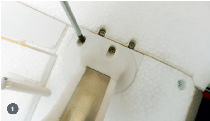
1) Schrauben sichern die Fahrwerksbügel über die Fläche auch am Rumpf. 2) Die Anlenkungen der Ruder werden durch Sicherungsclips gehalten. Der kleine Sporn am Heck schützt den Rumpf bei verpatzten Landungen vor Beschädigung
