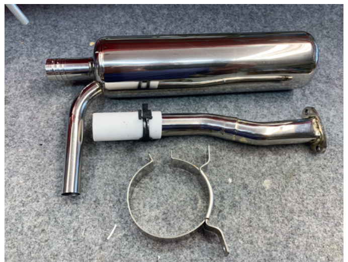
Nach dem Ausbau des alten Eigenbau-Dämpfers kam ein neues Vierkammer-System von Zimmermann ins Modell
