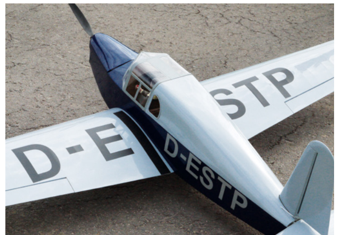
Abbildung 3: Die Siebel 202 ist ein Großmodell, das klassisch ganz aus Holz gebaut ist. Der Bau dauert eine Ewigkeit, aber dann weiß man das Modell auch zu schätzen
