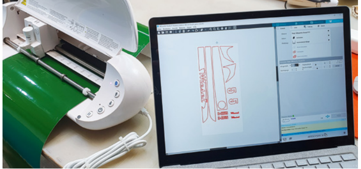
Die grafische Gestaltung ist bewusst reduziert gehalten. Die wenigen Farbflächen entstanden mit Hilfe eines Silhouette Portrait Schneidplotters und Oracal 751 C Werbebeschriftungsfolie. Die Vorlage ist Bestandteil des Downloadplans
