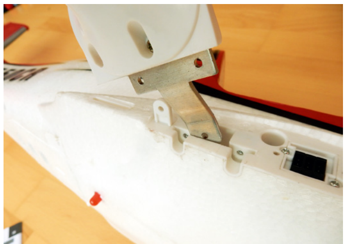
Die beiden Hauptfahrwerke werden in stabilen Taschen aufgenommen
