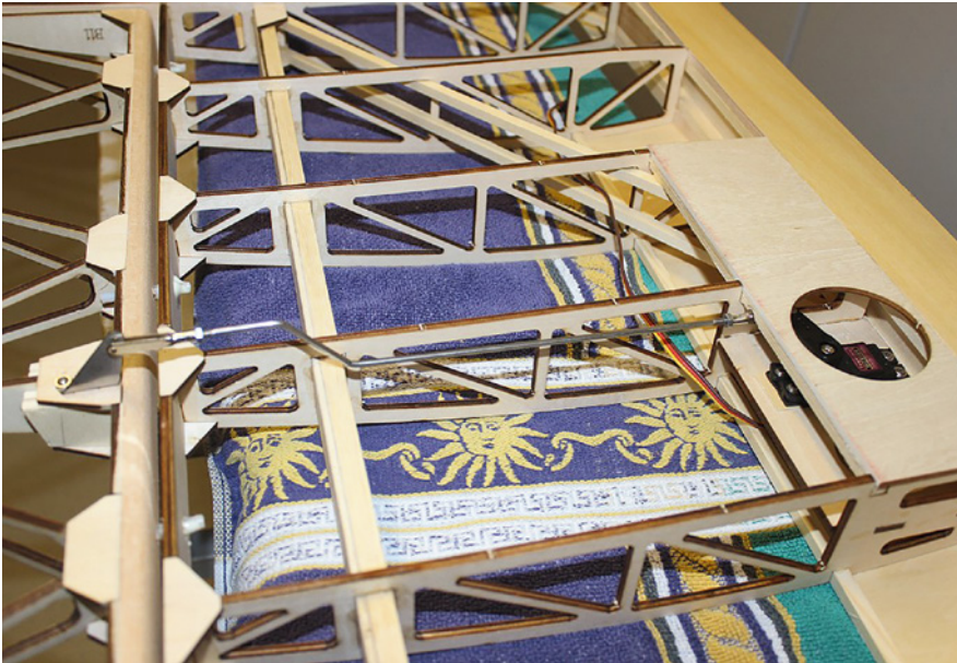
Die Servoverschraubung muss mit 1-mm-Sperrholz unterlegt werden, damit die Servos nicht über die Rippen hinausragen
