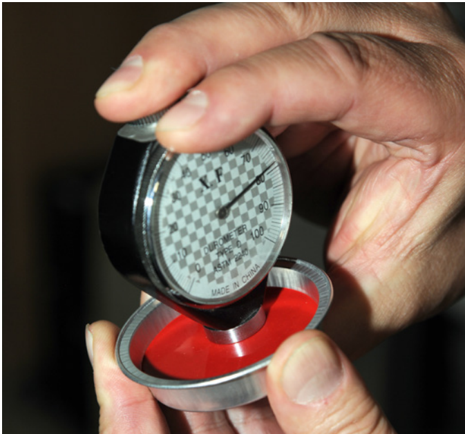
Messung der Shore-Härte, einer gängigen, effektiven Methode zur Werkstoffprüfung
