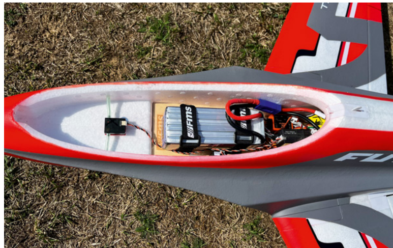
Aufgrund der großen Kabinenhaube ist der Innenraum gut zugänglich. Zum Einstellen des Schwerpunkts muss der Akku ganz nach hinten
