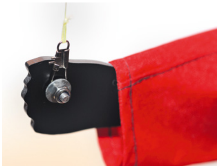
Die Befestigung der Bremsleinen kann auch ohne die D-Ringe sauber ausgeführt werden
