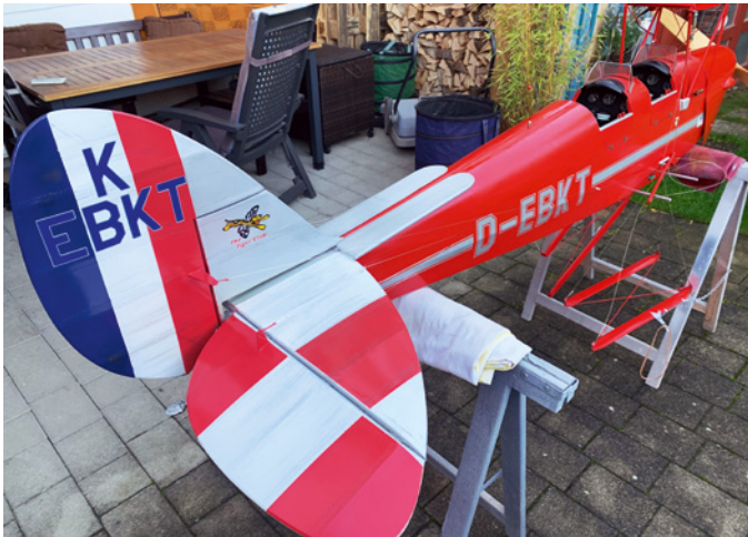
Beim sehr gut erhaltenen, 32 Jahre alten Modell waren ein paar Instandsetzungen, beispielsweise neue Seilanlenkungen, und vor allem Scale-Anpassungen erforderlich
