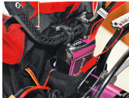
Der 4.000er-LiPo fügt sich perfekt in das Backpack ein. Er kann unter dem APS-Bügel eingeklemmt werden – dicker oder breiter darf er aber nicht sein
