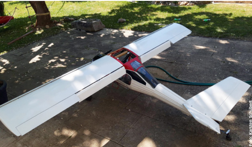
Abbildung 10: Die Wilga, hier als Modell mit besonderer Leitwerkskonstruktion, hat auch im Original einen gutmütigen, wenn auch widerstandsbehafteten Rechteckflügel
