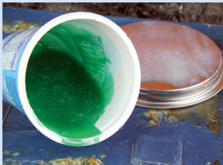
Das Harz HP-E25FB mit Härter und gering eingefärbt ist bereit für eine Testreihe
