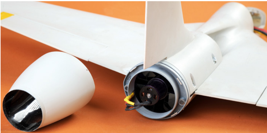
Der Antrieb ist fertig montiert und die Auslassdüse kann verbaut werden
