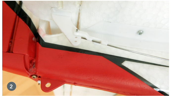
1) Schrauben sichern die Fahrwerksbügel über die Fläche auch am Rumpf. 2) Die Anlenkungen der Ruder werden durch Sicherungsclips gehalten. Der kleine Sporn am Heck schützt den Rumpf bei verpatzten Landungen vor Beschädigung
