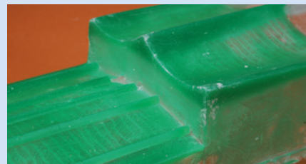
Der Test mit dem neuen Harz ist geglückt. Die Kanten sind sauber abgeformt
