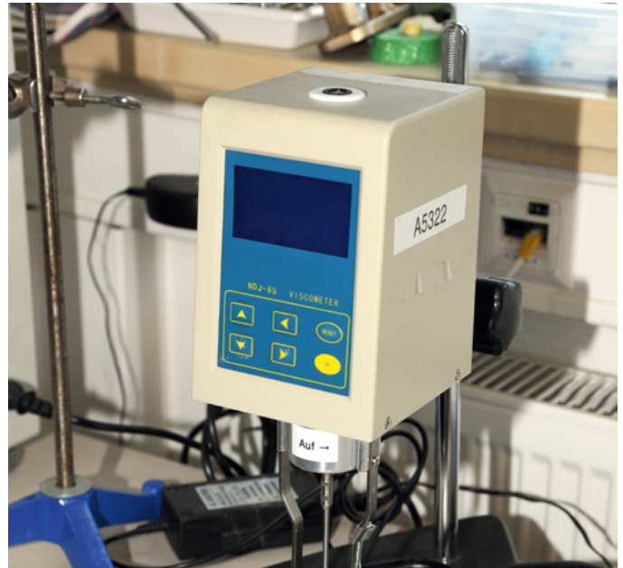
Mit diesem Laborgerät kann die Viskosität gemessen werden
