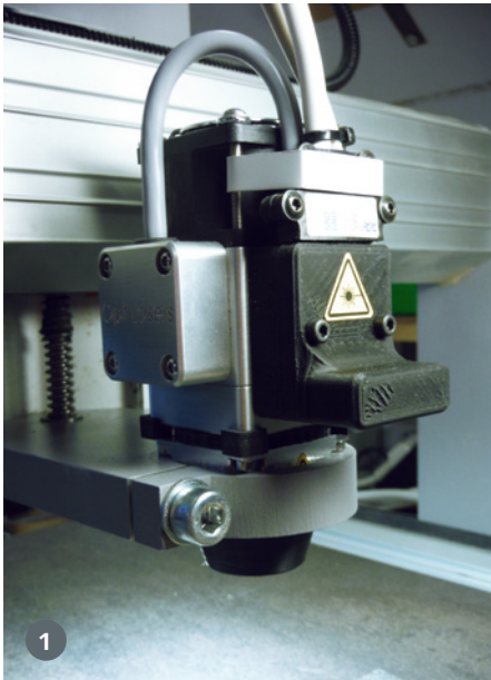
1) Abbildung 1a: Heute ist es nicht unüblich, in der Hobby-Werkstatt einen CNC-Diodenlaser zu finden. Er macht vieles leichter – doch Vorsicht, die Laserstrahlung ist hoch gefährlich für das ungeschützte Auge und die Haut! 2) Abbildung 1b: Ein für den Modellbau sehr gut geeigneter Laser ist der Dreamcut S von Mr Beam, der in FlugModell 7+8/22 vorgestellt wurde
