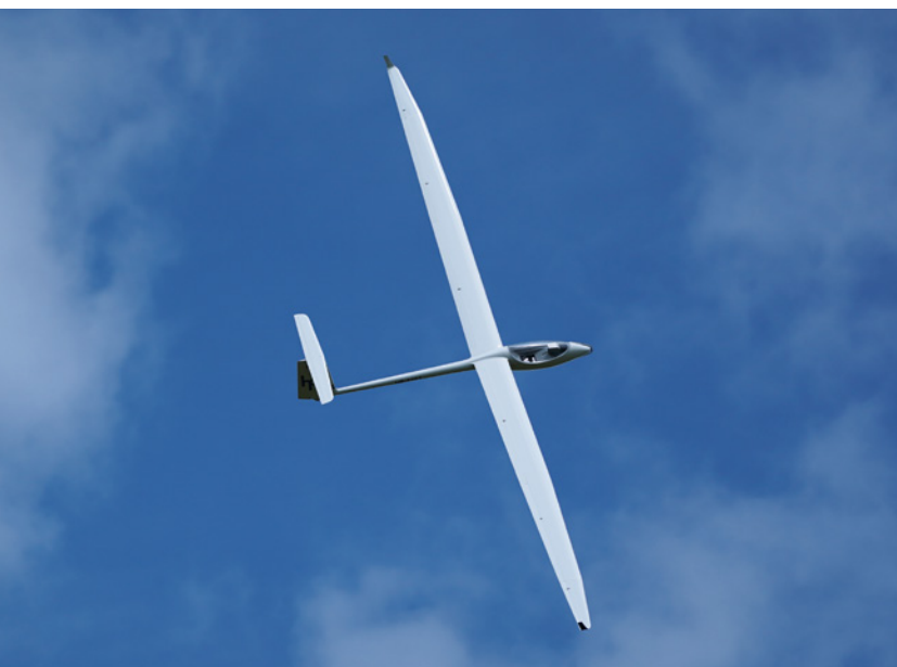
Abbildung 12: Moderne Hochleistungssegler zeichnet eine hohe Streckung aus, die jedoch bei Flugmodellen einen Maßstab im Bereich zwischen bis 1:2 bis 1:4 bedingt
