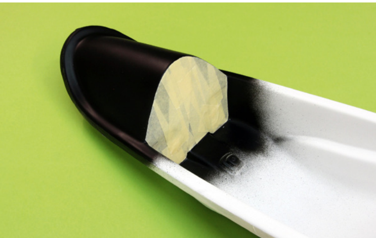
Der Instrumentenpiz vorne wurde schwarz matt lackiert, der Teil dahinter grau gesprenkelt
