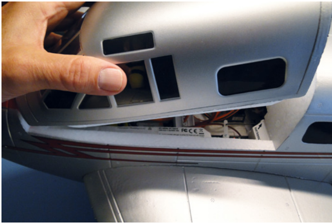
Über die große Cockpitöffnung lässt sich der Akku mühelos wechseln
