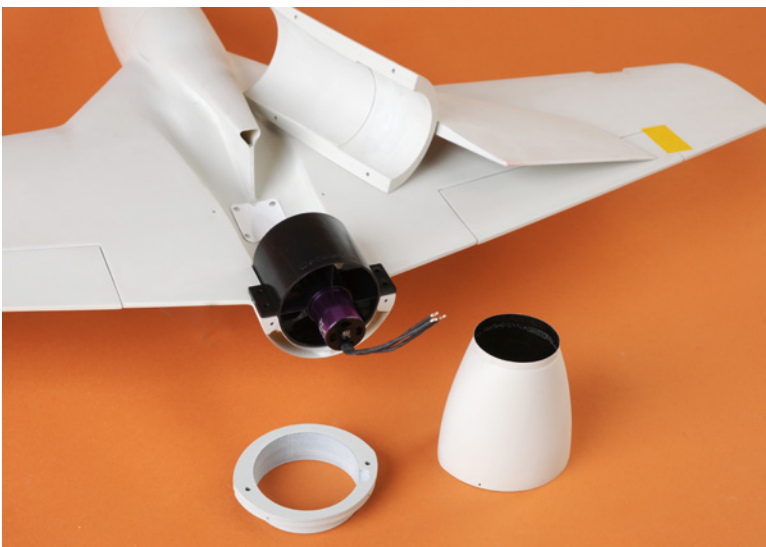
Der Fan passt exakt in die Aufnahmen und wird einfach im Heck montiert
