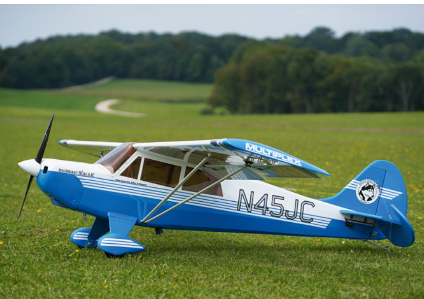
Abbildung 11: Typischer Vertreter eines Schleppmodells mit rechteckiger Flächengeometrie ist die Husky
