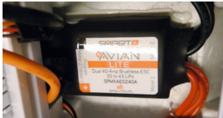
Der Avian Lite Dual-Regler beherbergt eigentlich zwei 40-A-Regler in einem Gehäuse und hat einige technischen Besonderheiten
