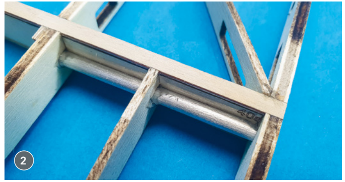
1) Alle Rippen besitzen ein Fübchen, sodass man auf dem ebenen Baubrett arbeiten kann. Ein 4-mm-Pappelsperholz-Rippenkamm dient gemeinsam mit zwei Aufleimern aus 1,5-mm-Birkensperholz als Hauptholm. 2) Die Flügelsteckung erfolgt mit zwei 3-mm-Stahldrähten, wozu passende Metallhülsen (Messing oder Aluminium) in den ersten beiden Hauptrippen direkt am Holm eingearzt werden. Dabei entsteht automatisch die korrekte V-Form
