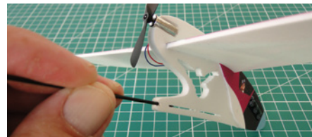
Der Leitwerksträger aus CFK wird mit Uhu Por im Rumpfvorderteil verklebt
