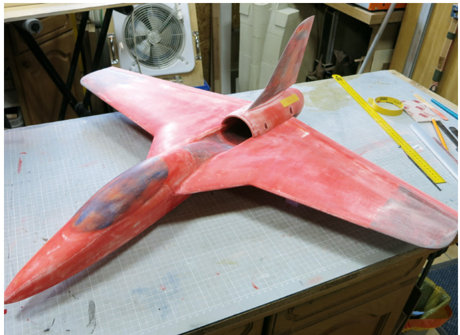
Erstes Experimentalmodell mit ungeteiltem Lufteinlass
