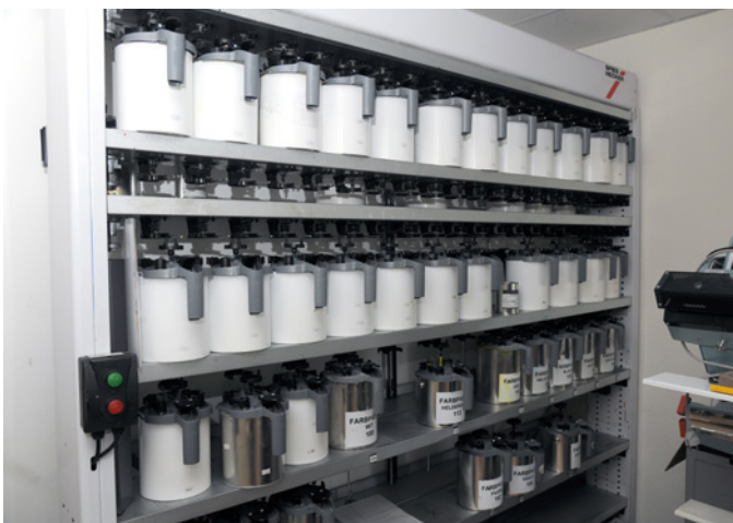
Mischraum mit der Batterie kleiner Vorratsbehälter. Gebinde und Mischtypen können flexibel erstellt werden
