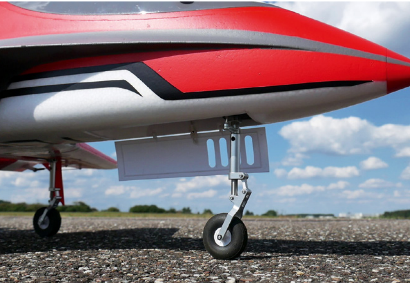
Ein Highlight ist das aus Metall bestehende, gefederte Einziehfahrwerk, so ist man auch für Starts und Landungen auf Rasenpisten gerüstet
