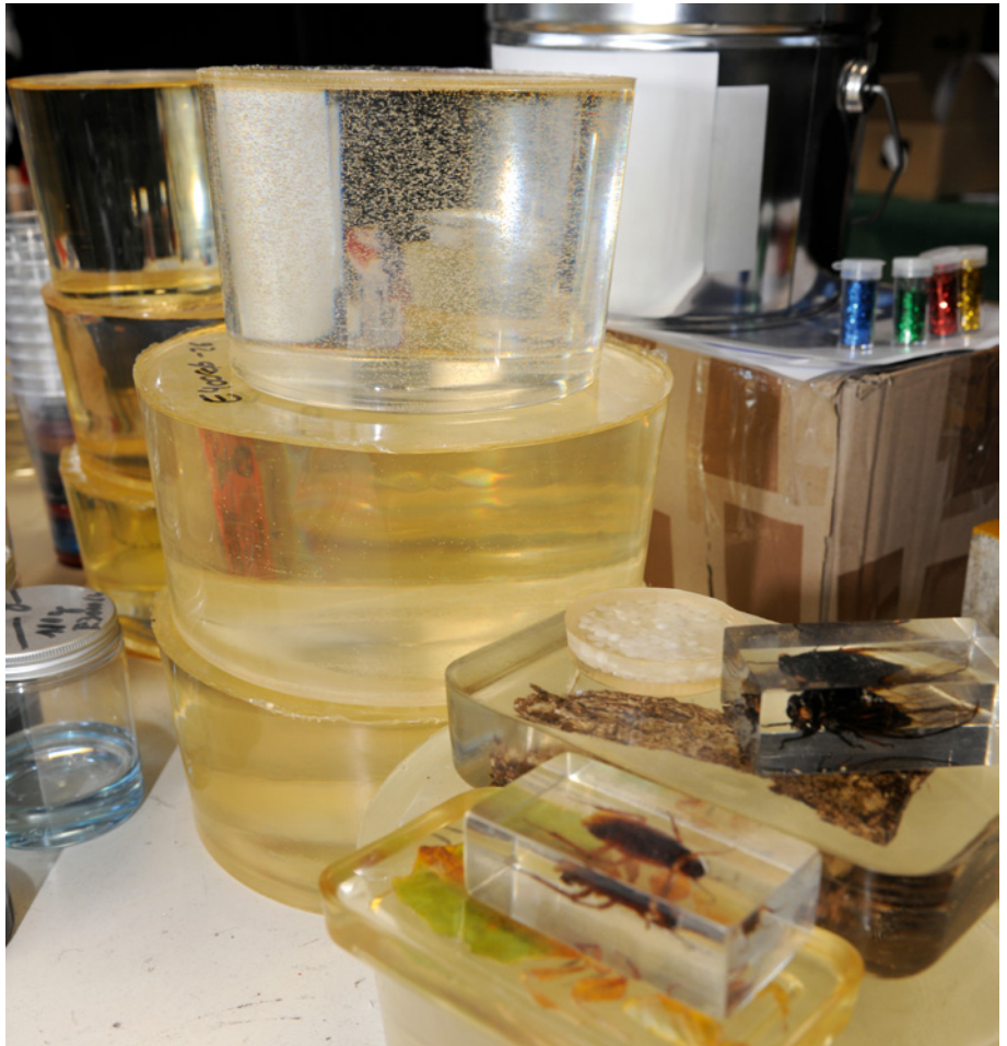
Testergebnisse bei Gießharz mit unterschiedlicher Viskosität/Temperatur. Im oberen Prüfling haben jede Menge Luftblasen nicht entweichen können
