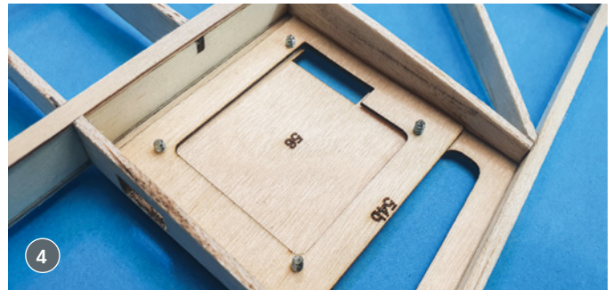
3) Die angenehme Flugstabilität von Wiesel wird auch durch die beiden abgewinkelten Flügelohren unterstützt. Sie bestehen außen aus robustem 1,5-mm-Sperholz, aufgedoppelt mit Nasenleisten-Aufleimern am Randbogen. 4) Die Querruder werden auf direktem Weg angelenkt – die Servos sitzen auf einem angeschraubten Deckel, um jederzeit wieder ranzukommen
