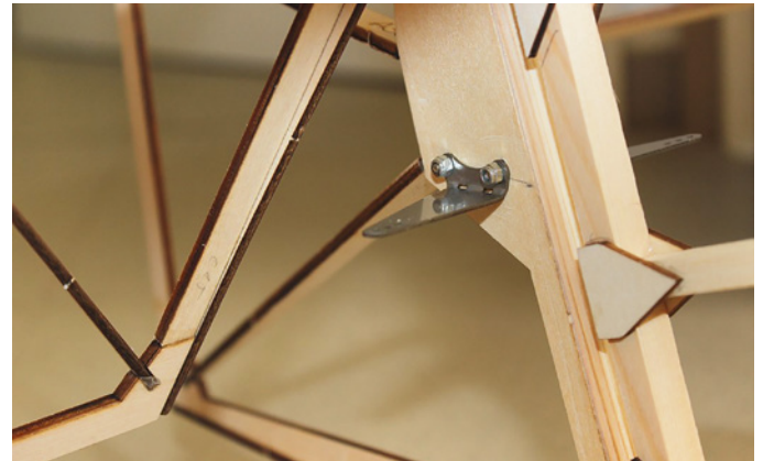
Das Gerüst wird am Ende mit 2-mm-Balsa beplankt. Verstärkungsecken ermöglichen das Anschrauben der Ruderhörner
