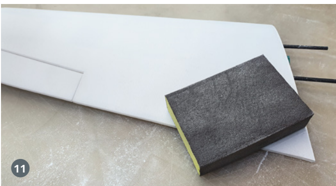
Sorgfältiges Anschleifen, zum Beispiel mit einem 120er-Schleifschwamm
