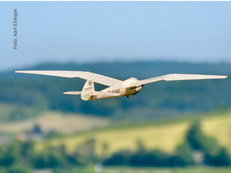
Abbildung 1: Der Möwenknick war keine gute Idee – schwer zu bauen und aerodynamisch ungünstig – und keiner wusste im Grunde, welchen Vorteil er bringen sollte
