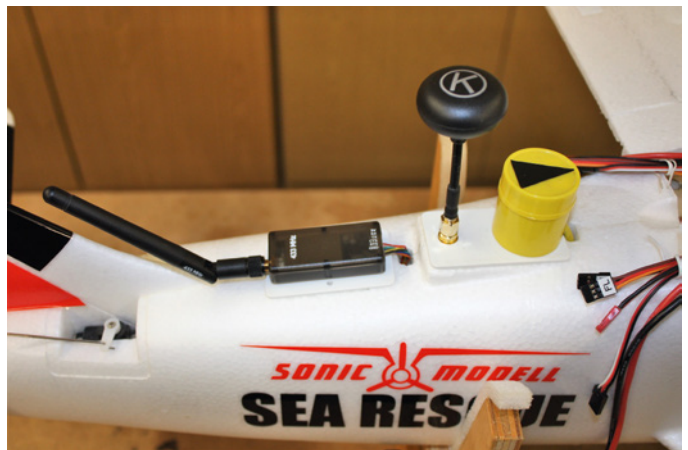
Hier stört sich hoffentlich nichts – Funkmodul des Flight Controllers mit Antenne, Video-Antenne und GPS-Modul mit Magnetkompass
