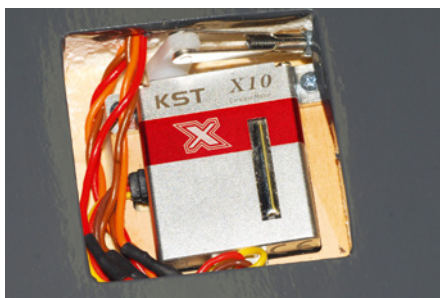
Sämtliche Flächenservos sind fertig angelenkt und eingebaut. In den Servoschächten liegt jeweils eine Kabelschleife, falls ein Austausch erforderlich sein sollte
