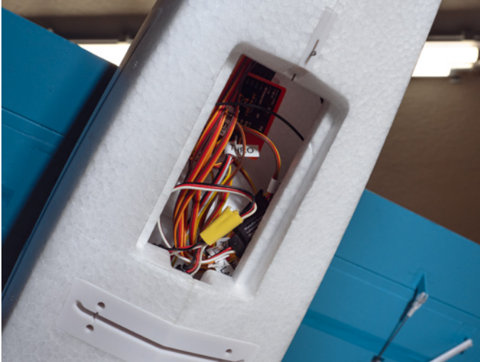
Unter dem Rumpf befindet sich der Zugang zu den Servokabeln und der Stabilisierungselektronik Reflex
