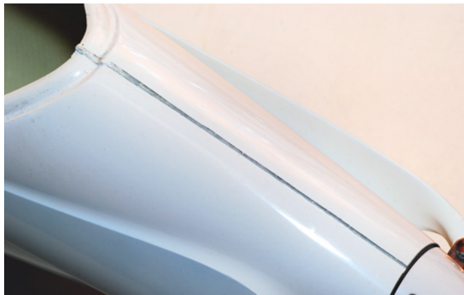
Die Naht von der Kabinenhaube zum Spinner ist etwas breit geraten, ansonsten glänzt der Rumpf durch seine makellose Oberfläche
