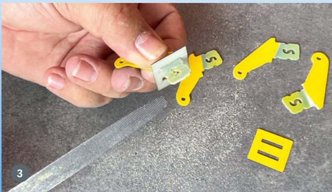
3) Das ist außergewöhnlich: Entsprechend der Verwendungsstelle sind die GFK-Ruderhörner in passender Farbe lackiert. An den Klebestellen muss natürlich die Farbe entfernt werden. 4) An der Unterseite des Motordoms findet der Regler seinen Platz. Für Vortrieb sorgt ein Dualsky XMotor GA 8000.9
