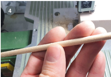
4 Zunächst ist die Oberfläche noch etwas grob und muss bearbeitet werden
