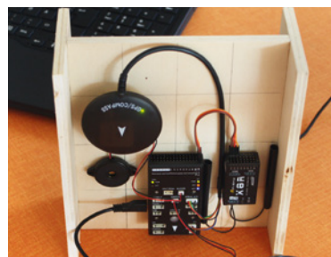
Referenzgestell für die Kalibrierung mit Empfänger, Flight Controller, GPS-Modul, Piepser und Safety Switch
