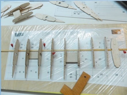
Der Flügel wird klassisch auf dem Plan und dem unteren Hauptholm aufgebaut
