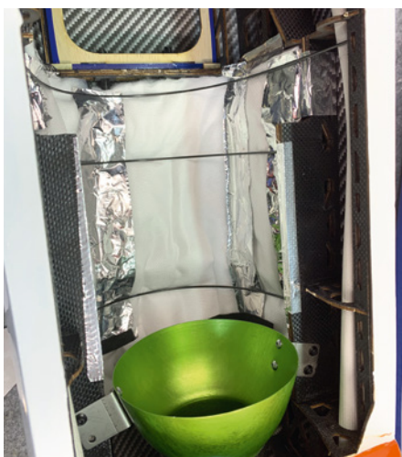
Ausgekleidet mit Vlies von MTM reduziert sich auch maßgeblich die Lautstärke der Turbine
