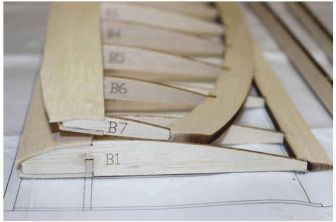
Sobald die Beplankung exakt zugeschliffen ist, kommt die Nasenleiste dran
