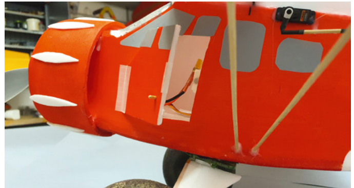
Der Akkuwechsel erfolgt durch eine Tür in der Seitenwand
