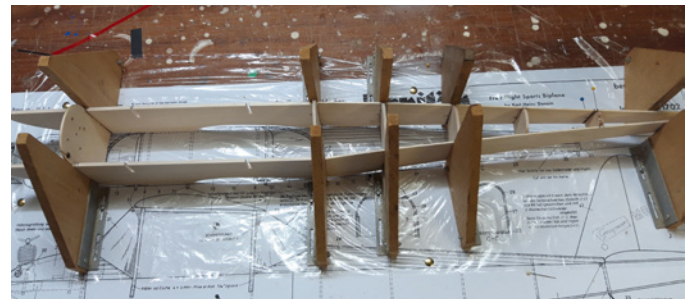
Mit Hilfe von Montagewinkeln ist eine genaue und sichere Fixierung der Rumpfteile möglich
