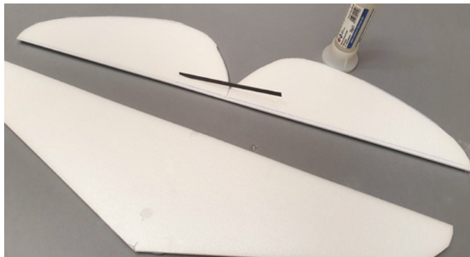
Das CFK-Flachprofil verhindert, dass sich die Höhenrudershälften gegeneinander verdrehen können
