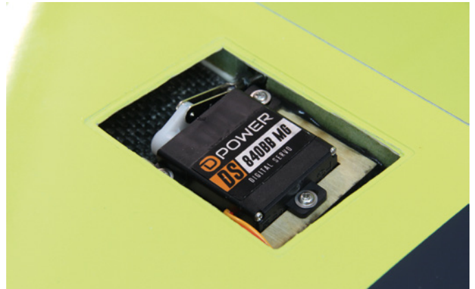
Die Servos werden mit den mitgelieferten Schrauben in die Rahmen geschraubt und mit den Anlenkungen verbunden.
