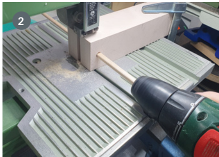
2 Grundlage des Hilfswerkzeugs ist ein PUR-Hartschaum-Kunststoffblock
