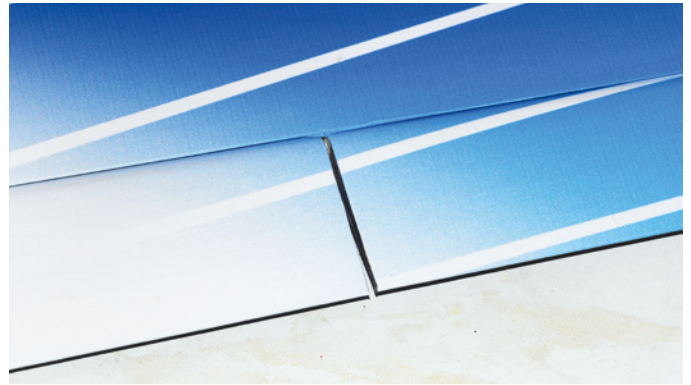
Unten angeschlagene Elastic-Flap-Ruder mit einer Einlaufippe oben ergeben kleinstmögliche Ruderspalte
