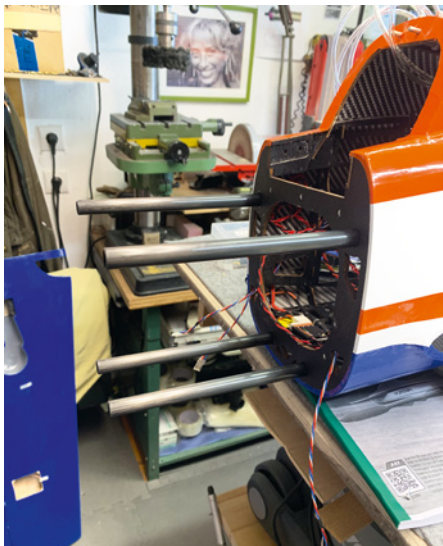
Der Rumpf ist geteilt, sodass sich die MB 339 auch im kompakten Pkw oder zusammen mit anderen Modellen transportieren lässt
