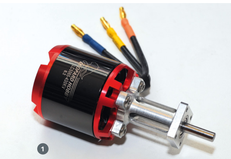
1) Die FES-Verlängerung ermöglicht den Einsatz von großen Motoren in Verbindung mit kleinen Spinnern. So steht auch ohne Getriebe genügend Antriebsleistung für schwere Segler zur Verfügung und es macht die Sache günstiger. 2) State of the Art: Spinner und Luftschraube in Weiß passen optimal zum weißen GFK-Rumpf
