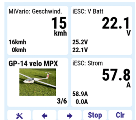
Darstellung der Telemetriedaten in Verbindung mit einem Jeti-Sender
