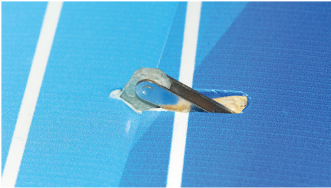
Die Überkreuz-Anlenkungen stehen auf der Oberseite nur minimal über und sind bereits herstellerseitig eingeharzt
