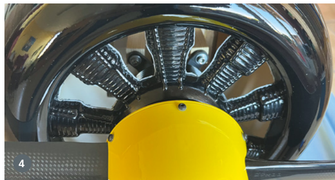
3) Ruderhörner in zur Folie passender Farbe und Gestänge mit Rechts-links-Gewinde zur komfortablen Verstellung ohne Ausclipsen. 4) Die tiefgezogene Sternmotorenattrappe muss leider noch mit Durchbrüchen versehen werden – das hätte ich mir vom Hersteller fertiggestellt gewünscht
