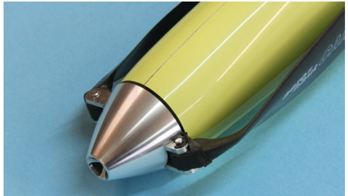
Der Spinner passt sehr gut zur Rumpfkontur, leider steht die 15 x 10-Zoll-Luftschraube etwas weit vom Rumpf ab – da könnten Propeller anderer Hersteller idealer sein
