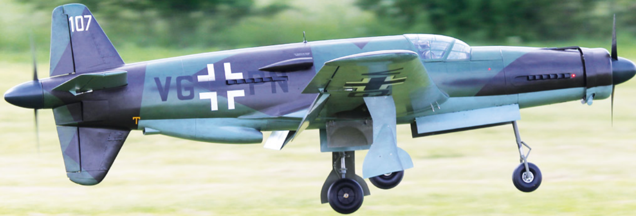
Abbildung 6: Die Dornier Do-335 benötigt im Grunde weder beim vorderen noch beim hinteren Propeller einen Seitenzug
