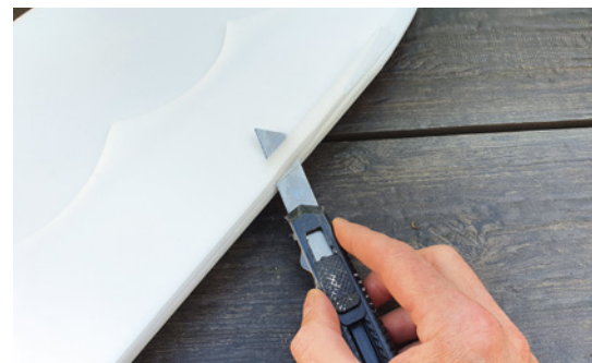
Die Nasenleiste wird zuerst grob in Form geschnitzt und dann mit 180er- oder 240er-Schleifpapier rund geschliffen
