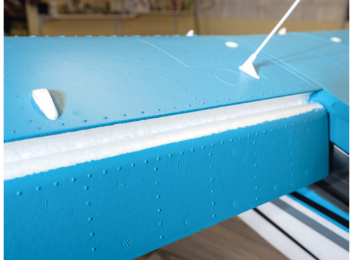
Die Landeklappen kommen ohne Kunststoffscharniere aus und schlagen weit nach unten aus
