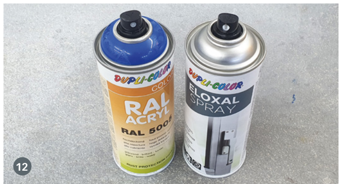
Gut abgesperrt, ist auch ein dünner Auftrag Acryl-Farblack möglich
