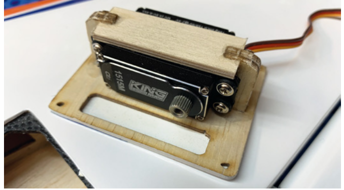
Im gesamten Modell sind acht Servos installiert, die allesamt von Kingmax/Unilight stammen
