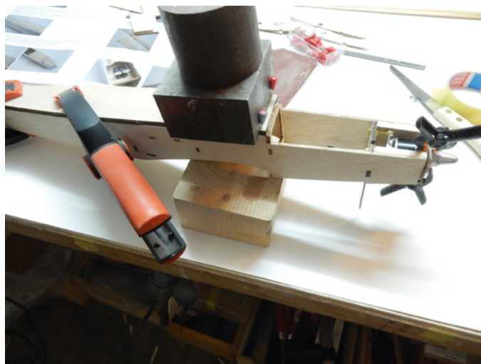
Rumpfrücken und Boden sind eher von der massiven Art und wollen beim Verkleben entsprechend in Lage gehalten werden
