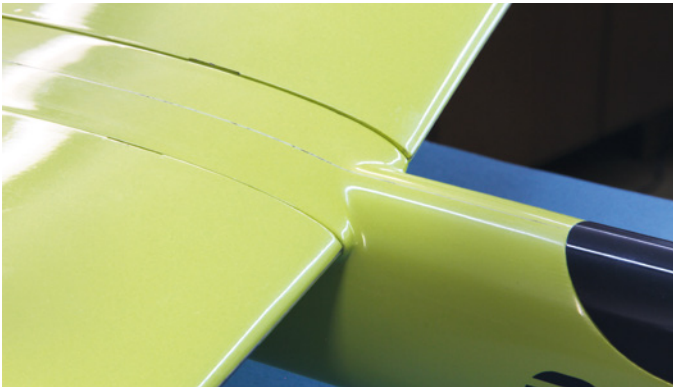
Die linke Tragfläche zeigt einen kleinen Überstand zur Rumpfanformung, da der Anstellwinkel bei den Tragflächen jedoch identisch ist, wurde dies so belassen
