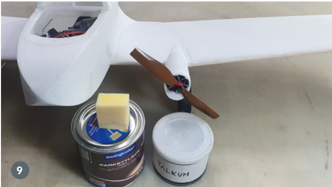
Rezept für eine prima Grundierung: Parkettlack und Talkumpulver
