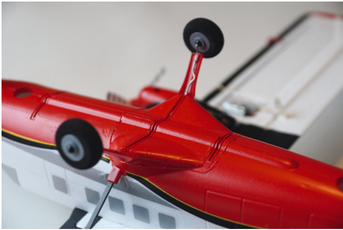
Die Rumpfunterseite hat mehrere Aufnahmen für das Landfahrwerk und die Streben der Schwimmer
