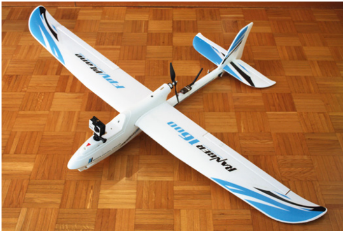
Der Ranger 1600 von Volantex hier mit Kamera-Plattform, Action Cam und 433-MHz-Funkmodul für den Flight Controller
