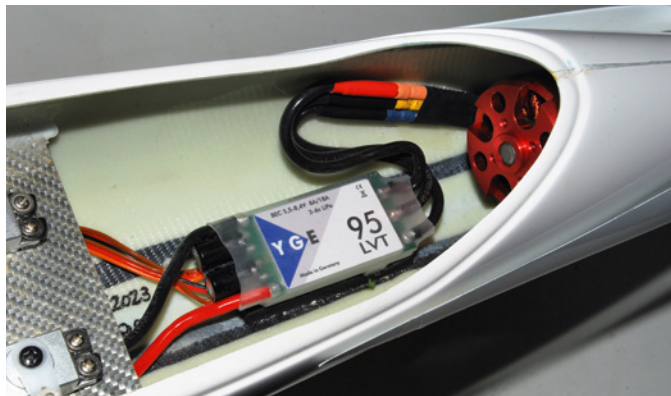
Die Drehzahlregelung des Reisenauer-Antriebs übernimmt ein YGE 95 LVT
