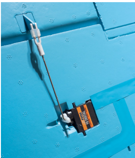
Zwar lassen die Gewindestänge eine Feinjustage zu, doch ab Werk sitzt alles perfekt
