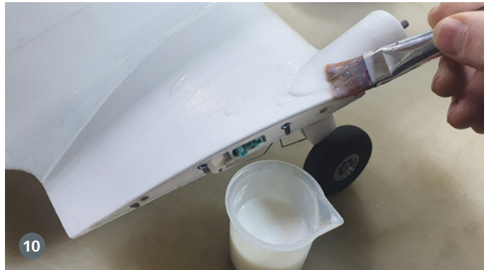
Feinste Unebenheiten und Poren werden hierbei gut verfüllt
