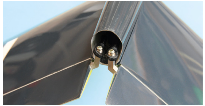
Die beiden Kugelhöpfe müssen außen etwas geschliffen werden, damit sie bei Vollausschlag nicht aneinanderstoßen
