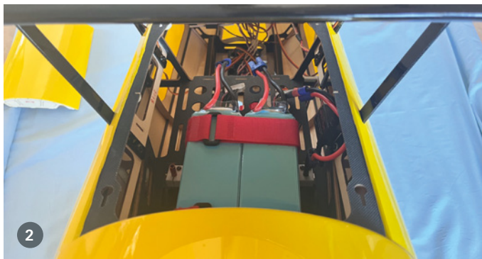
1) Rechts das Seitenruderservo, in der Mitte der AR9020-Empfänger, daneben das Stabilisierungssystem Aura 8, unten auf dem Steckungsrohr finden die beiden 2.100-mAh-Empfänger-Akkus ihren Platz. 2) Blick ins Innere zum 12s-Antriebsakku nach Entfernen der vorderen oberen Rumpfabdeckung. Beim Akkuwechsel ist alles komfortabel zugänglich
