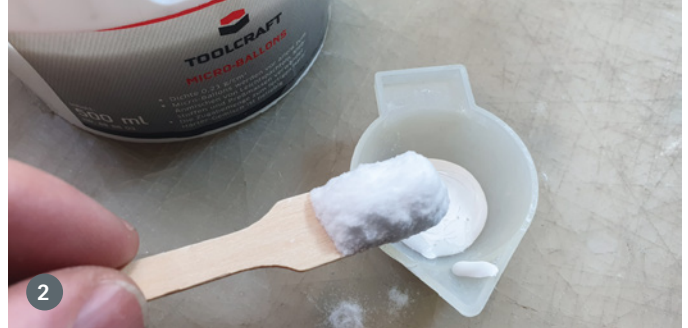
2 In die Wandfarbe rührt man etwa zum gleichen Anteil Microballons ein
