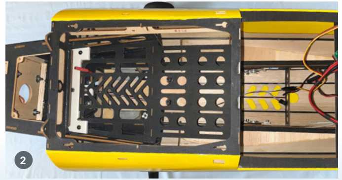
1) Im Modell kommen ausschließlich Servos von Savöx zum Einsatz, und zwar das SH-1271TG+, ein HV-Digitalservos der 30-kg-Klasse. 2) Die vordere obere Rumpfabdeckung ist über einen Schiebeseitz demontierbar. Diese wird lediglich über die vier passgenauen Nasen fixiert. Das erleichtert insbesondere bei der Elektroversion den Akkuwechsel
