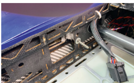
Ab Werk verlegte Geflechschläuche erleichtern das Führen der Kabel. Viel CFK verstärkt die Holzkonstruktion und sorgt für enorme Festigkeit
