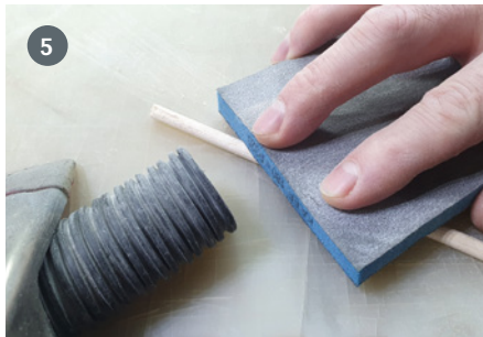
5 Beim Schleifen ist es durchaus sinnvoll, den Staub gleichfalls abzusaugen
