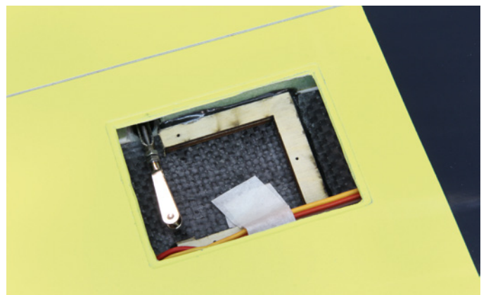
Eingeklebte Servorahmen, verlegte Servokabel, sogar das Gestänge ist schon vormontiert, mehr ARF geht nicht
