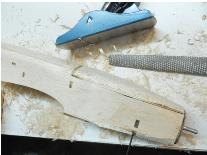
Anfangen mit Zugsäge, weiter über Hobel und Raspel bis hin zum Feinschliff ist die Rumpfform herauszuarbeiten
