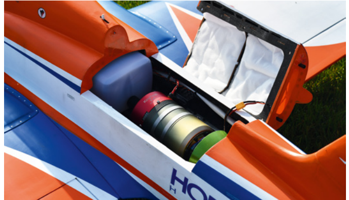
Mit der Turbine Kingtech K 85 G4 steht der MB 339 sehr viel Leistung zur Verfügung
