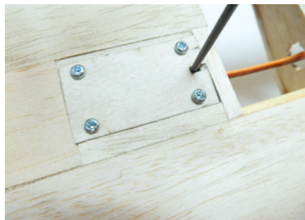
Neben dem Regler finden im Akkufach dreizellige LiPos bis 1.300 mAh Kapazität Platz
