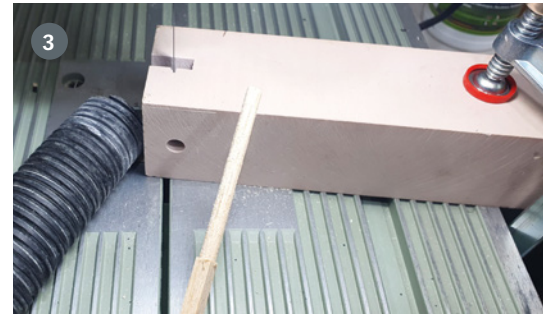
3 Ein seitlicher Einschnitt ermöglicht das Platzieren des Bandsägeblatts
