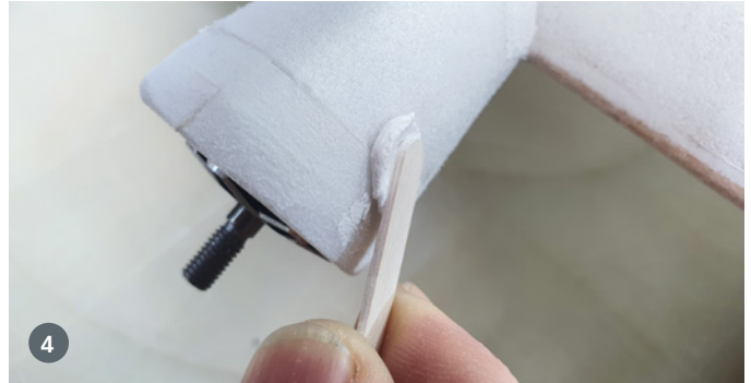
4 Risse, Klebestellen, Unebenheiten: ein dünner Auftrag genügt
