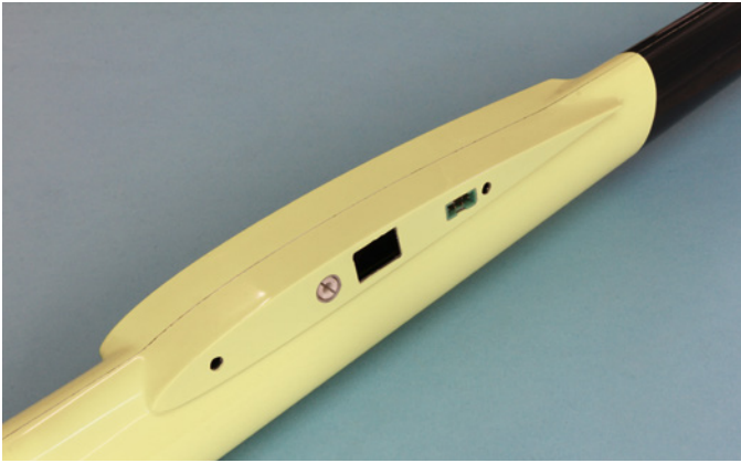
Im Bereich der Tragflächensteckung sind Steckung, Servo-Steckverbindungen und sogar der Flächenschnapp ab Werk betriebsfertig und passgenau eingebaut
