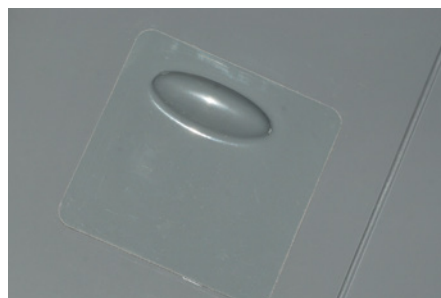
Die Abdeckungen für die Servoschächte sind aus GFK gefertigt und passen farblich einwandfrei. Die Befestigung mit Kontaktkleber hält zuverlässig und der Deckel kann bei Bedarf wieder geöffnet werden
