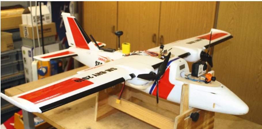
Die voll ausgerüstete Binary von Sonic Model. Zusätzlich zur Ausrüstung des Rangers sind hier noch eine FPV-Kamera und die zugehörige Video-Antenne zu sehen. Das GPS-Modul mit Kompass befindet sich in der gelben Verkleidung
