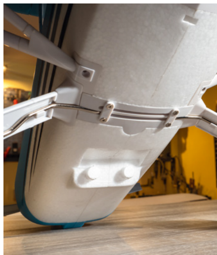
Ein stabiles Kunststoffinlay nimmt den Fahrwerksdraht auf und wird mit zwei Halterungen gesichert
