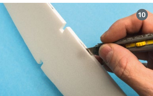
10) Im weichen Depron kommen wir mit der zuvor markierten Cutterklinge bequem vorwärts. Das alles ist eine Sache der Übung und des guten Augenmaßes. 11) Mit einem Zahnstocher kann man sich das Einbringen von Weißleim leichter machen, indem man den Spalt ein wenig aufweitet. 12) Danach wieder an drei, vier Stellen einmal kurz auf die Tube drücken, und zwar bei sämtlichen Scharnierpositionen hintereinander
