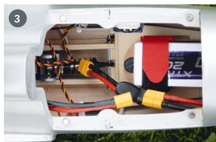
1) Ein Vorteil beim geteilten Rumpfbau ist, dass man nach dem Abnehmen von der Helling ganz bequem „von unten“ die RC-Komponenten einbauen kann. 2) Das Schleppkupplungs-Servo im Bug unter dem Akkubrett. 3) Der Akku ist durch die Cockpitöffnung gut erreichbar
