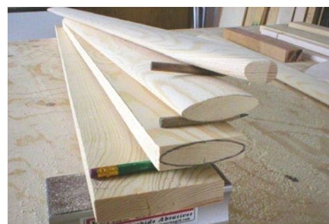
Die Flächenstreben sind buchstäblich aus dem Vollholz geschnitzt
