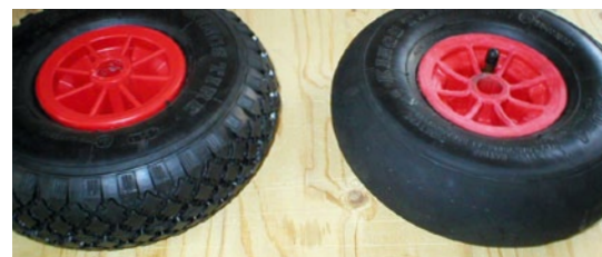
Mit dem Cuttermesser ließ sich das Reifenprofil entfernen (rechts). Weitere Maßnahme erleichterten das Rad zusätzlich
