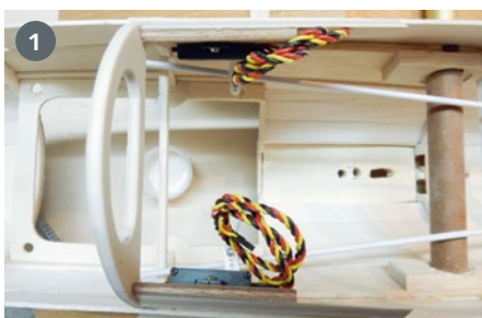
1) Ein Vorteil beim geteilten Rumpfbau ist, dass man nach dem Abnehmen von der Helling ganz bequem „von unten“ die RC-Komponenten einbauen kann. 2) Das Schleppkupplungs-Servo im Bug unter dem Akkubrett. 3) Der Akku ist durch die Cockpitöffnung gut erreichbar
