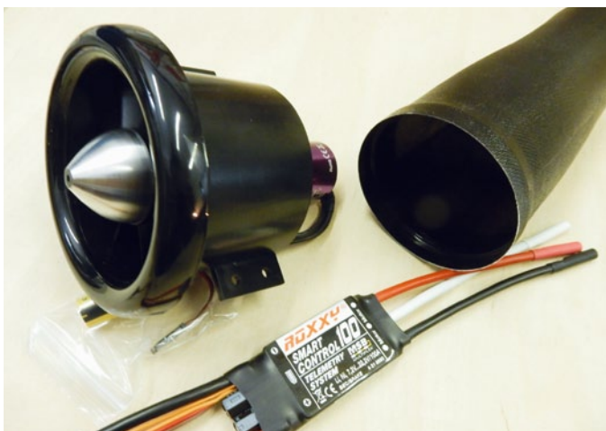
Ein Wemotec-Impeller mit Hacker-Motor sowie roxy-Regler hauchen der Fouga Leben ein
