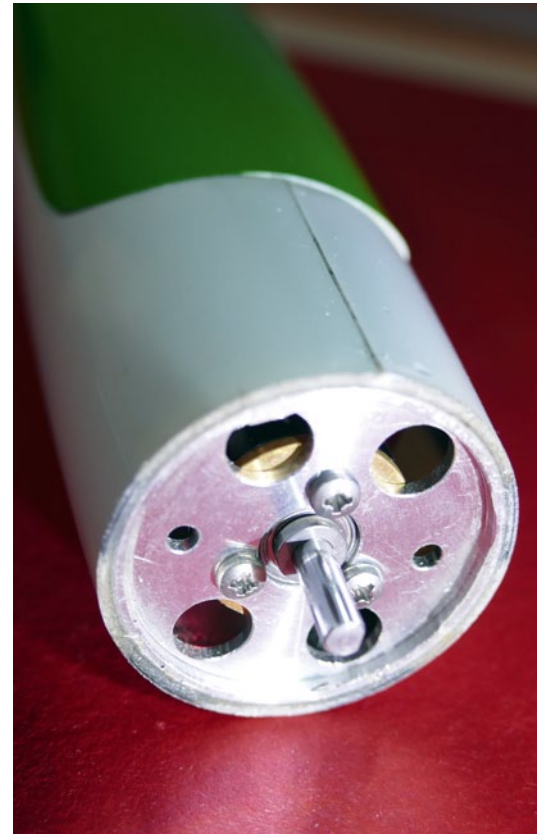
Der Universal-Motorspant aus Luftfahrtaluminium von Leuka CNC-Technik wurde selbst einlamiert
