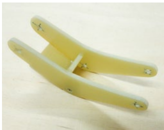
Aus der selbst gebauten Fahrwerksschwinge entsteht das Fahrwerk, das dann mit einem Öldruckstoßdämpfer ausgestattet im Rumpf eingebaut wird
