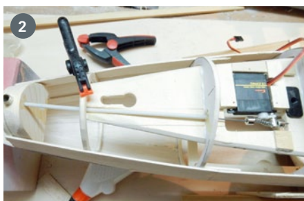
1) Ein Vorteil beim geteilten Rumpfbau ist, dass man nach dem Abnehmen von der Helling ganz bequem „von unten“ die RC-Komponenten einbauen kann. 2) Das Schleppkupplungs-Servo im Bug unter dem Akkubrett. 3) Der Akku ist durch die Cockpitöffnung gut erreichbar
