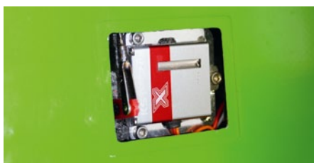
In der Fläche wurden Alu-Rahmen zum Einbau der KST-Servos eingearzt
