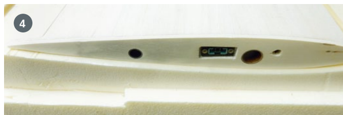
1) Der Bau des Flügels erfolgt in einer Negativform aus Hartschaum, wobei nach dem Einkleben des unteren Holms schon die Rippen verklebt werden können. 2) Unterer und oberer Holm werden mit senkrecht stehendem Balsaholz verkastet. 3) Die Ausschnitte für die Servos und das Durchfädeln der Servokabel erfolgen, bevor die obere Beplankung aufgebracht wird. 4) Hier erkennt man nochmals, dass der Flächenbau in einer Negativform erfolgte – die Wurzelrippe ist dran
