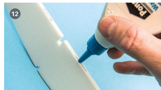
10) Im weichen Depron kommen wir mit der zuvor markierten Cutterklinge bequem vorwärts. Das alles ist eine Sache der Übung und des guten Augenmaßes. 11) Mit einem Zahnstocher kann man sich das Einbringen von Weißleim leichter machen, indem man den Spalt ein wenig aufweitet. 12) Danach wieder an drei, vier Stellen einmal kurz auf die Tube drücken, und zwar bei sämtlichen Scharnierpositionen hintereinander
