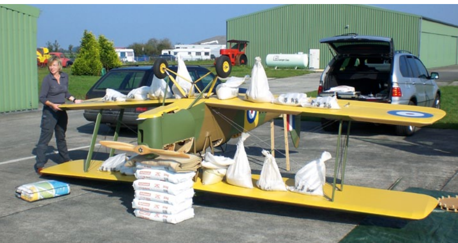
Prozedur bei der Zulassungsprüfung. Flächen und Leitwerk werden positiv mit dem dreifachen des Rumpfgewichts belastet, was etwa 120 kg entspricht
