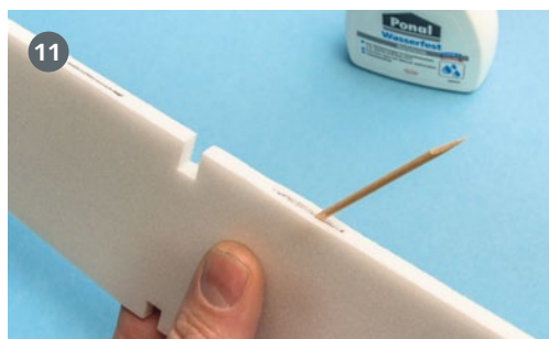
10) Im weichen Depron kommen wir mit der zuvor markierten Cutterklinge bequem vorwärts. Das alles ist eine Sache der Übung und des guten Augenmaßes. 11) Mit einem Zahnstocher kann man sich das Einbringen von Weißleim leichter machen, indem man den Spalt ein wenig aufweitet. 12) Danach wieder an drei, vier Stellen einmal kurz auf die Tube drücken, und zwar bei sämtlichen Scharnierpositionen hintereinander
