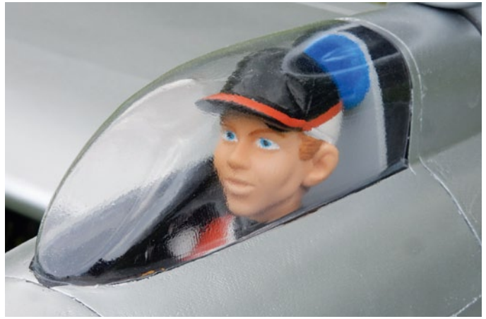
Die Form für die Haube wurde direkt aus der Cockpitverkleidung angefertigt und dann aus Klarsichtmaterial tiefgezogen. Im Cockpit herrschen recht beengte Verhältnisse für den Piloten
