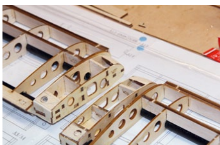
Flügelstummel und Außenflügel, die verleimt wurden
