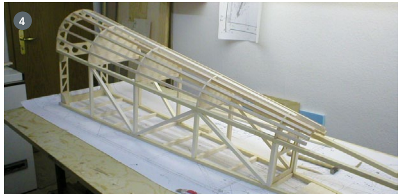
1) Mühsames Anfertigen der Befestigungselemente für die Spannseile aus 2-mm-Messingblech. 2) Die Ruderhörner entstanden aus 3 mm dickem „Novotex“ Phenolharzhartgewebe. 3) Wie in alten Zeiten werden die Konturen der Spanten mit „Blaupapier“ auf das 6-mm-Sperrholz übertragen. 4) Die hintere Rumpfhälfte lässt sich mit konventionellen Methoden aufbauen, sprengt jedoch übliche Dimensionen
