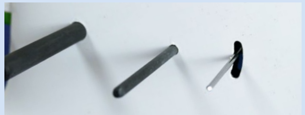
So sieht alles vor dem Erstflug aus – aber der Höhenruderdraht drückt gegen das Laminat
