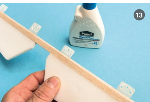
13) Im Prinzip wiederholen wir ja alles bisher Getätigte, denn nun kommt ebenfalls ein Strich Leim auf jede Seite der herausstehenden Scharnieroberflächen. 14) Aufgrund der genauen Anzeichnung und der ebenso genauen Einschnitte lassen sich Ruder und Flosse mühelos zusammenstecken. 15) Es darf gern ein kleiner, aber gleichmäßiger Spalt von etwa 0,5 bis maximal 1 mm bleiben. Dadurch kann man letzte Leimreste auch prima mit dem Zahnstocher beiseiteschieben
