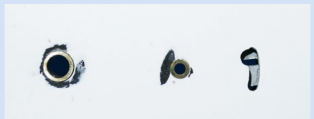
Selbst eingebaute Buchsen und ein angepasstes Lager sorgen nun wieder für präzise Ruderbewegungen
