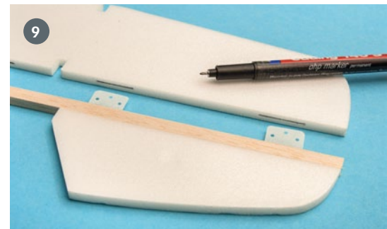
7) Auch das Scharnier selbst bekommt eine Behandlung mit Leim, damit wir trockene und somit nicht verleimte Stelle weitestgehend ausschließen können. 8) Rein damit, bis zur Mitte, und in etwa gerade ausrichten. Es quillt etwas Leim hervor, perfekt, den muss man nur wegwischen. Ausgehärteter Holzleim ist dauerelastisch und stört als dünner Film überhaupt nicht. 9) Auch auf der Gegenseite zeichnen wir zuerst möglichst genau mittig die Position an, damit die schwächenden Einschnitte nicht unnötig groß geraten müssen
