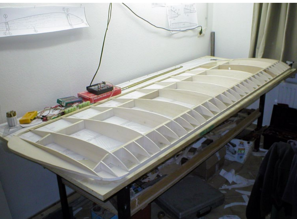
Eine der oberen Flächenhälften ist im Rohbau fertig. Um sich die Dimensionen auszumalen: hier liegen über 2,5 m Spannweite und 1 m Flächentiefe auf dem Tisch
