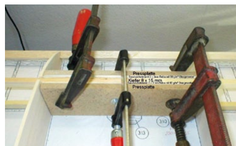
Die Holme haben einiges zu tragen und sind mit entsprechender Akribie zu bauen
