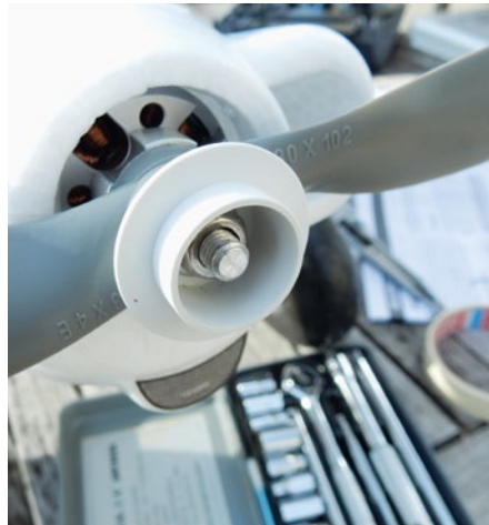
Der Topf dient zur Aufnahme des ELAPOR-Spinners, der fast spaltfrei sitzt und rund läuft
