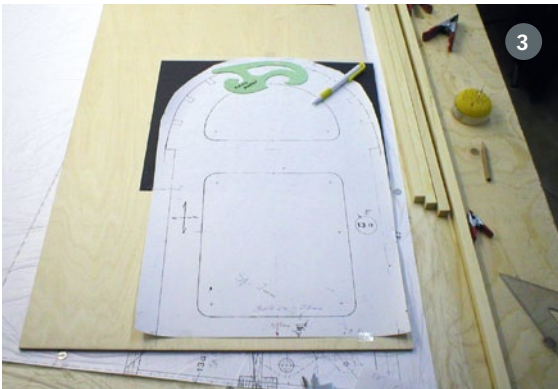
1) Mühsames Anfertigen der Befestigungselemente für die Spannseile aus 2-mm-Messingblech. 2) Die Ruderhörner entstanden aus 3 mm dickem „Novotex“ Phenolharzhartgewebe. 3) Wie in alten Zeiten werden die Konturen der Spanten mit „Blaupapier“ auf das 6-mm-Sperrholz übertragen. 4) Die hintere Rumpfhälfte lässt sich mit konventionellen Methoden aufbauen, sprengt jedoch übliche Dimensionen
