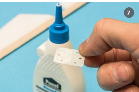
7) Auch das Scharnier selbst bekommt eine Behandlung mit Leim, damit wir trockene und somit nicht verleimte Stelle weitestgehend ausschließen können. 8) Rein damit, bis zur Mitte, und in etwa gerade ausrichten. Es quillt etwas Leim hervor, perfekt, den muss man nur wegwischen. Ausgehärteter Holzleim ist dauerelastisch und stört als dünner Film überhaupt nicht. 9) Auch auf der Gegenseite zeichnen wir zuerst möglichst genau mittig die Position an, damit die schwächenden Einschnitte nicht unnötig groß geraten müssen
