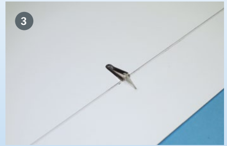
1) Die Ruderhörner wurden mit weiß eingefärbtem Langzeitharz eingeklebt, was für eine gute Optik sorgt. 2) Die M2,5-Gewindestangen bieten ausreichend Justierweg, um die Ruderausschläge optimal anpassen zu können. 3) Auch die Flügel Oberseite mit den selbst gebauten Überkreuzanlenkungen kann sich sehen lassen
