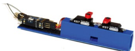
3D-gedruckter Servo-Empfängereinschub, hergestellt von einem Fliegerkollegen – das kann man aber auch aus Holz bauen
