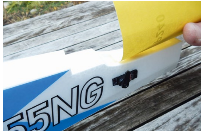
Das Bauen beschränkt sich auf das Anrauen der Klebeflächen
