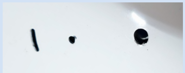
Nach etlichen Flügen zeigten sich Spuren an den Lagern
