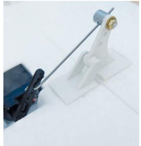
Dieses Servo macht mit seinem langen Hebelweg eine Super-Luftbremse aus der Landeklappe
