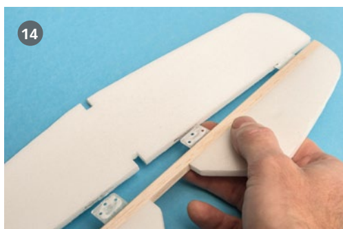
13) Im Prinzip wiederholen wir ja alles bisher Getätigte, denn nun kommt ebenfalls ein Strich Leim auf jede Seite der herausstehenden Scharnieroberflächen. 14) Aufgrund der genauen Anzeichnung und der ebenso genauen Einschnitte lassen sich Ruder und Flosse mühelos zusammenstecken. 15) Es darf gern ein kleiner, aber gleichmäßiger Spalt von etwa 0,5 bis maximal 1 mm bleiben. Dadurch kann man letzte Leimreste auch prima mit dem Zahnstocher beiseiteschieben
