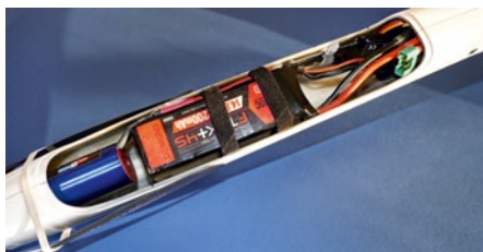
Abhängig von der gewählten Ausrüstung geht es im Rumpf enger zu als man sich das wünschen würde, da der Schwerpunkt ja ohne Bleizugabe erreicht werden soll
