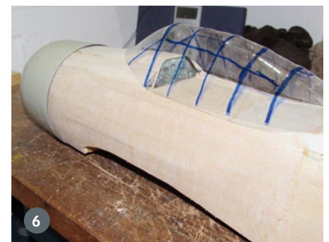
5) Um den Rumpf bulliger zu gestalten, wird ein keilförmiger Gurt erstellt. 6) Nach dem Beplanken mit 1,5-mm-Balsaholz und schleifen wird die typisch runde Form erkennbar
