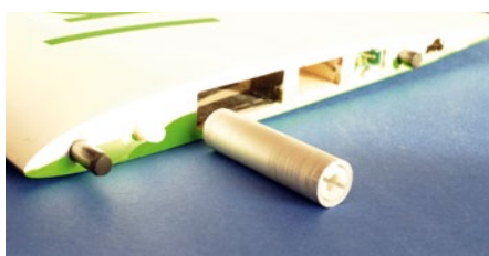
Später wurde die herausnehmbare Multiplex Multilock-Flächensicherung im Alurohr doch noch nachgerüstet
