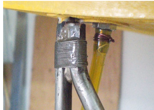
Die 8-mm-Edelstahlstreben sind hartverlötet und mit Stahlitze umwickelt, die mit Epoxydharz getränkt sind, damit sich diese keinesfalls aufgrund der Vibrationen lösen können
