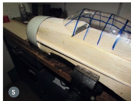
5) Um den Rumpf bulliger zu gestalten, wird ein keilförmiger Gurt erstellt. 6) Nach dem Beplanken mit 1,5-mm-Balsaholz und schleifen wird die typisch runde Form erkennbar
