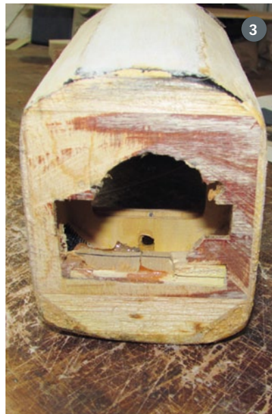
1) Die Haube der AT6 musste als nächstes demontiert werden. 2) Für die A6M-Replika ist eine neue, anders geformte Haube tiefgezogen worden. 3) Dass der Motorspant ausgewechselt werden musste, war spätestens ab jetzt klar. 4) In diesem Schritt wurde ein Teil der Frontpartie gleich mit erneuert
