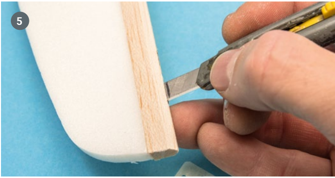
5) Bis hierher und nicht weiter wird der Schlitz Stück für Stück nachgearbeitet, besonders in den Ecken. Das Scharnier freut sich bereits auf seinen ersten Probesitz
