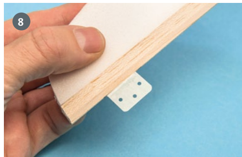
7) Auch das Scharnier selbst bekommt eine Behandlung mit Leim, damit wir trockene und somit nicht verleimte Stelle weitestgehend ausschließen können. 8) Rein damit, bis zur Mitte, und in etwa gerade ausrichten. Es quillt etwas Leim hervor, perfekt, den muss man nur wegwischen. Ausgehärteter Holzleim ist dauerelastisch und stört als dünner Film überhaupt nicht. 9) Auch auf der Gegenseite zeichnen wir zuerst möglichst genau mittig die Position an, damit die schwächenden Einschnitte nicht unnötig groß geraten müssen
