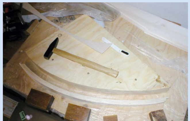
Der Randbogen ist getrocknet und kann am Leitwerk verbaut werden
