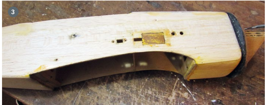
1+2) Das Reparieren von Brüchen und Rissen am Rumpf steht am Anfang. Hier reicht eine Balsaplatte aus. 3) Die ölige Seitenwand wurde im Anschluss erneuert
