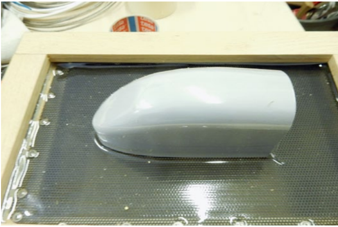
Die Form für die Haube wurde direkt aus der Cockpitverkleidung angefertigt und dann aus Klarsichtmaterial tiefgezogen. Im Cockpit herrschen recht beengte Verhältnisse für den Piloten
