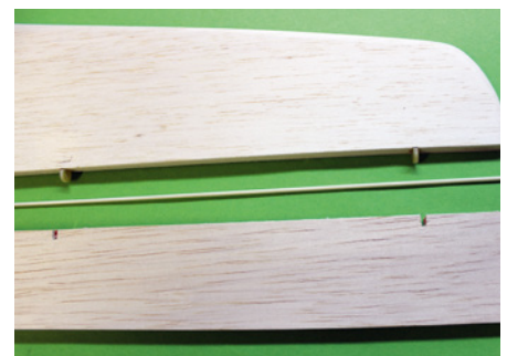
Ein besonderes Detail ist, dass die Ruderblätter abnehmbar befestigt werden
