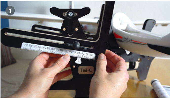
1.) Unten ist an der Skala des Flächenanschlags die Schwerpunktposition einzustellen. Oben dient die pendelnd gelagert Wippe zum Ausbalancieren einer aufgelegten Fläche in Schwerpunktlage. 2.) Der Flächenanschlag verhindert zum einen, dass das aufgelegte Modell nach vorne rutscht, und dient zum anderen zur Orientierung
