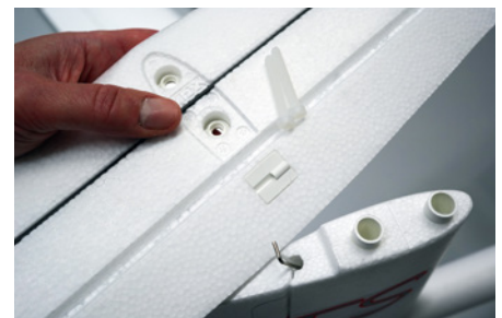
Einhaken des Rudergestänges im Ruder-Gegenlager, Leitwerk festschrauben, mehr ist nicht zu tun
