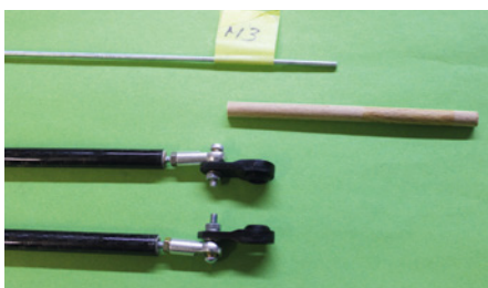
Als Schubstangen für die V-Leitwerks-Ruder kommen CFK-Rohre mit 8 mm Durchmesser zum Einsatz
