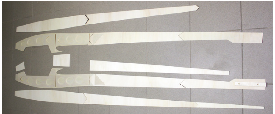
Alle Rumpfteile bestehen aus 3-mm-Sperrholz und die korrekte Montage ergibt sich unmissverständlich beim Zusammensetzen
