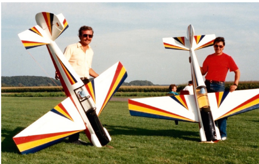
Zwei in den 1980er-Jahren in Eigenregie erstellte Dalotel 230 in Styro-Balsa-Bauweise. Die Ähnlichkeit zur modernen Version ist hoch
