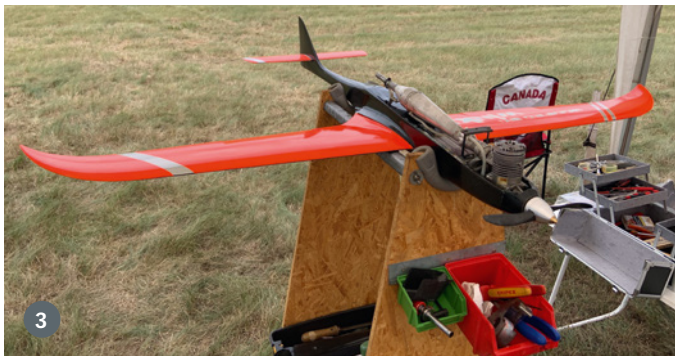
1.) Zu empfehlen ist der Heizkoffer von ETLZ, den man über Höllein beziehen kann. 2.) Hier stehen drei Modelle für den Flug fertig vorbereitet – kompromisslos ist die Platzierung des Antriebs als direkte „Rumpfverlängerung“. 3.) Das Modell von Stefan Winkler für die Klasse C-D mit 10 cm 3 . Der Rumpf ist vom Weirich-Speeder und die Fläche stammen vom Segler Blade der Marke X-Modell. 4.) Verschiedene Modelle mit 3,5-cm 3 -Motor für die Klasse F3Speed-A. Man sieht, der Einstieg ist auch mit weniger hochgezüchteten Boliden möglich
