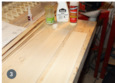
2.) Diese Abbildung zeigt ein extremes Beispiel, wie sehr sich Planken aufwerfen können, trotz Wässerns und Fixieren mit Nadeln. Das lässt sich verhindern. 3.) Diese beiden Planken sollten Stoß-auf-Stoß verklebt werden, allerdings nicht konventionell, also mit Ponal, sondern mit Titebond. 4.) Zuerst beide Planken – gerade Stoßkanten vorausgesetzt – Stoß-auf-Stoß legen und mit einem Tesastreifen fixieren, und zwar lückenlos. Anschließend eine Planke auf die andere klappen.
