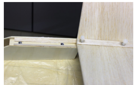
Endgültige Befestigung des V-Leitwerks mit zwei M6-Nylonschrauben am Rumpfe – das steigert die Transportfreundlichkeit
