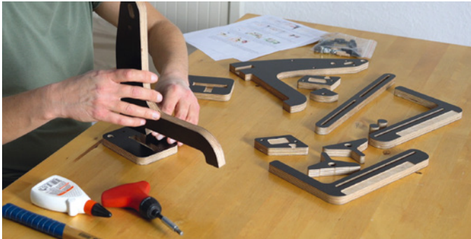
Ponal Express eignet sich ideal zum Verkleben der Holzteile. Zuvor einmal alles probehalber zusammenstecken
