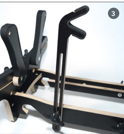
1.) Unten ist an der Skala des Flächenanschlags die Schwerpunktposition einzustellen. Oben dient die pendelnd gelagert Wippe zum Ausbalancieren einer aufgelegten Fläche in Schwerpunktlage. 2.) Der Flächenanschlag verhindert zum einen, dass das aufgelegte Modell nach vorne rutscht, und dient zum anderen zur Orientierung
