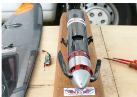
1.) Streckermotor an einem Monster 1.1 von HJK. Motor- und Rumpfdurchmesser gehen quasi nahtlos ineinander über, um so wenig Widerstand wie möglich zu haben. 2.) Ein Helikopter Typ TDR2 von Henseleit mit einem Kontronik-Antrieb. 3.) Ein Typhoon von Dr. Marcus Koch. Mit diesem Modell wurde Tim Moldtmann Zweiter der Deutschen Meisterschaft im Speedfliegen 2020. 519 km/h flog das 2.100 mm spannende, 3.818 g wiegende und mit einem Motor Scorpion HK5040, Regler YGE 160HV sowie einem 16s-LiPo Quantum 3000 65C ausgestattete Modell
