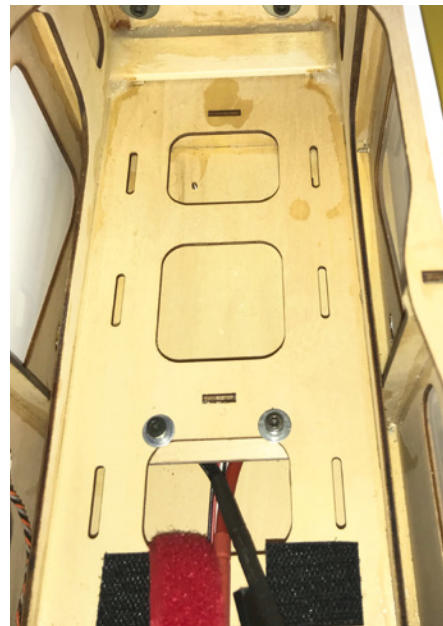
Der Akkublock wird über ein Akkubrett Marke Eigenbau im Rumpf sicher arretiert
