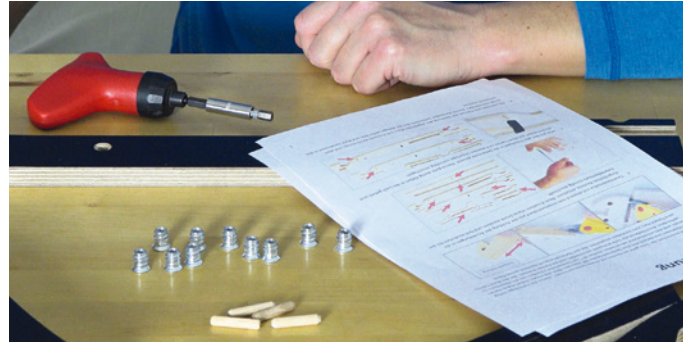
Zum hochwertigen Zubehör gehören Gewindehülsen, die mit einem Inbusschraubendreher einzusetzen sind
