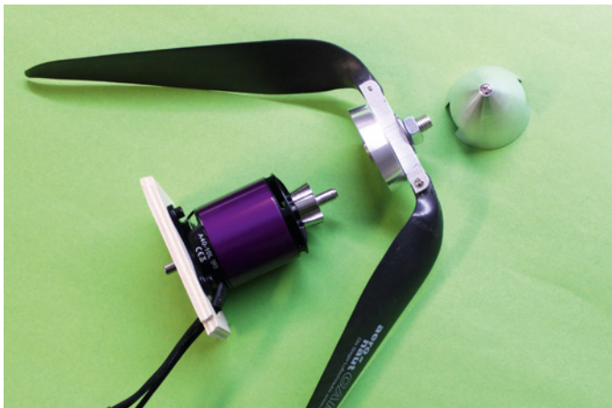
Motor mit Klapp-Propeller und Spinner. Das Ganze lässt sich so sehr gut in der Rumpfspitze einbauen
