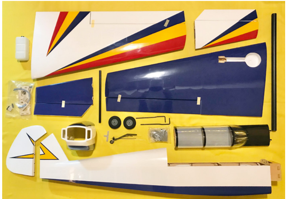
Die Dalotel 230 von Schweighofer kommt weit vorgefertigt zum Kunden und ist, außer der GFK-Motorhaube, komplett aus Holz aufgebaut
