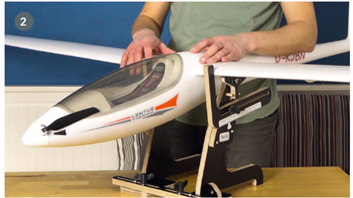
1.) Unten ist an der Skala des Flächenanschlags die Schwerpunktposition einzustellen. Oben dient die pendelnd gelagert Wippe zum Ausbalancieren einer aufgelegten Fläche in Schwerpunktlage. 2.) Der Flächenanschlag verhindert zum einen, dass das aufgelegte Modell nach vorne rutscht, und dient zum anderen zur Orientierung
