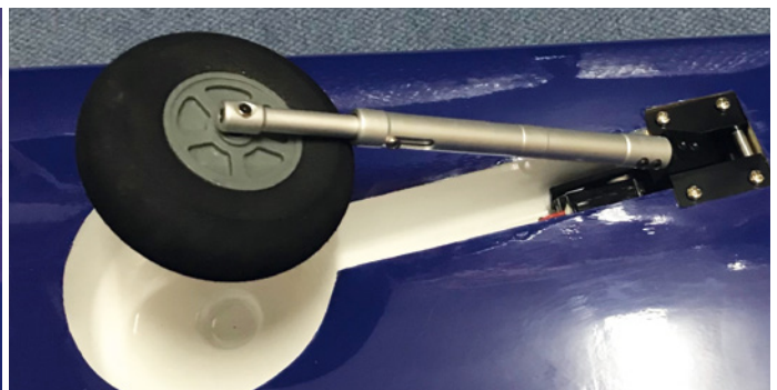
Zum Lieferumfang gehören Fahrwerksbeine aus 6-mm-Stahldraht ohne Federwindung (links). Im Laufe des Tests wurden die starren Stahldraht-Beine gegen solche mit Dämpfer von Lado ausgewechselt – etwas mehr Komfort darf sein
