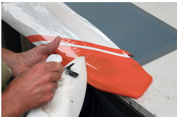
Zuerst wurden die Enden angeklebt, bevor die Folie mit Heißluft geschrumpft wurde. Das Leinentuch ums Bügelleisen ist kein Muss, hilft aber
