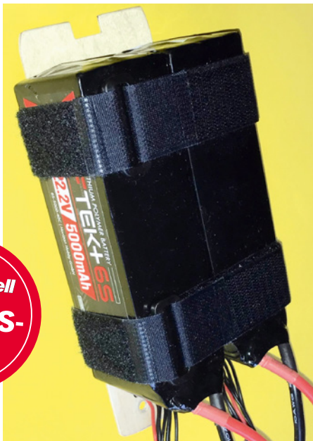
Der Akkublock wird über ein Akkubrett Marke Eigenbau im Rumpf sicher arretiert
