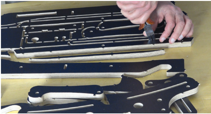
Mit einem Seitenschneider lassen sich die Stege, die absichtlich beim Fräsen stehen gelassen wurden, sauber durchtrennen
