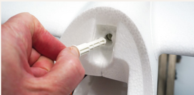
Eingeführt wird der Dorn über die Kabinenhaube. Zum Herausziehen empfiehlt sich die Zuhilfenahme eines abgewinkelten Inbusschlüssels
