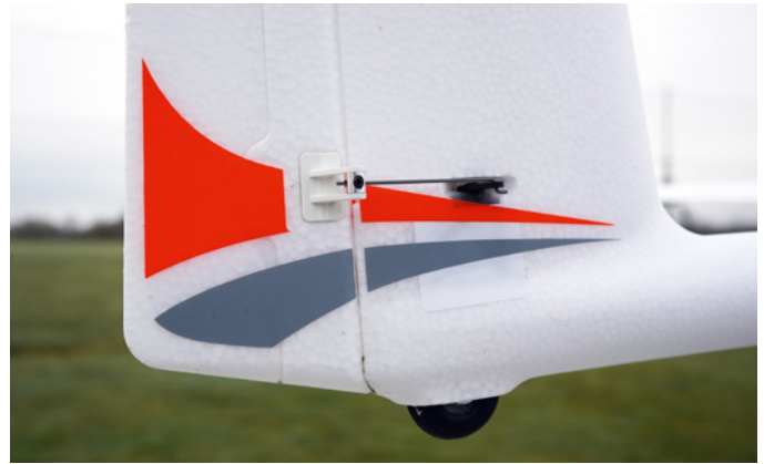
Das Seitenruder ist über Scharniere befestigt. Sollte das Servo einmal ausgetauscht werden müssen, braucht man nur den Klebestreifen abzuziehen
