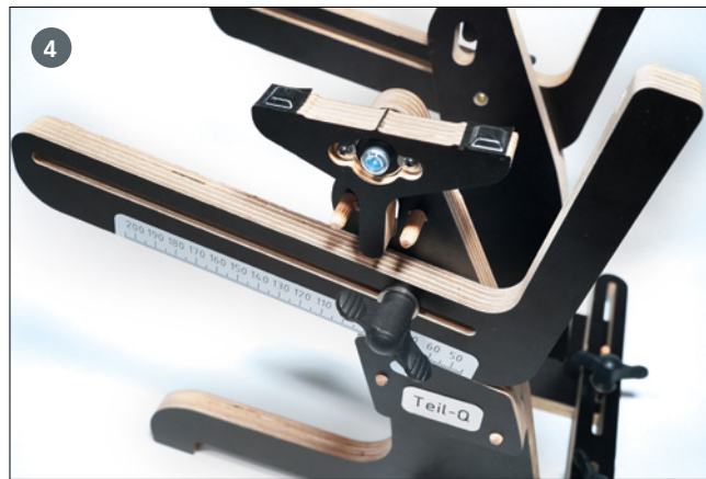
3.) In diesem Ausleger (Wing-Fix) kann man einen Flügel mit der Nasenleiste voran einsetzen und den Modellständer auch bei nur einer montierten Fläche einsetzen. 4.) Die Auflagefläche ist kugelgelagert und wie eine Wippe ausgelegt. Dübel begrenzen den Ausschlagwinkel auf maximal 10°. Die Erhebung wurde schwarz markiert, um die korrekte Schwerpunktposition besser kontrollieren beziehungsweise sehen zu können
