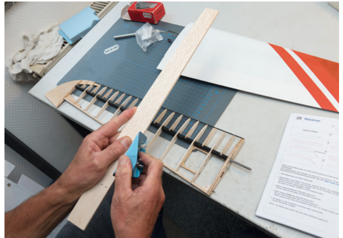
Anpassen der Querruder-Fase mit dem Balsahobel. Mit Fingerspitzengefühl stellt sich eine gleichmäßig schräge Kante ein
