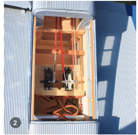
1.) Raritäten wie die Junkers G-38 bereichern den Modellflug – davon dürfte es gerne mehr geben. 2.) Wartungsklappe in der Rumpfmittle für den Zugang zum Höhen- und Seitenruderservo
