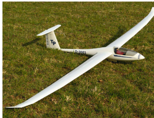
Abbildung 4: Die Ventus 2c hatte in der Profilanformung beziehungsweise Höhenleitwerkaufnahme eine negative EWD – das musste natürlich vor dem Erstflug korrigiert werden
