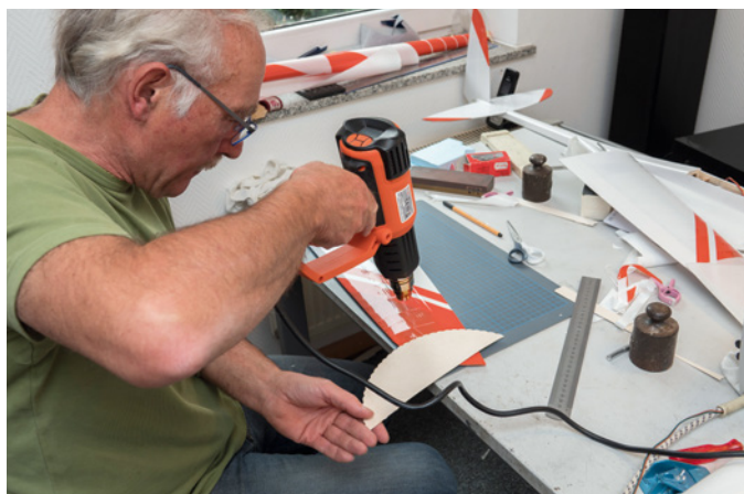
Mit einem temperaturgeregelten Heißluftfön kann man die Spannung aufbauen. Bereits verklebte Teile sollten abgedeckt werden
