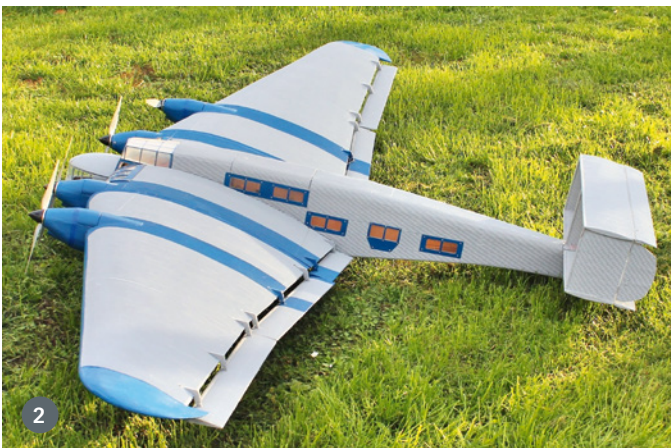
1.) Die in die Fläche voll integrierten Motorgondeln sind so üppig, dass Antriebe dort spielend Platz finden. 2.) Trapezflügel waren in den 1930er-Jahren durchaus verbreitet, man denke nur an die Entwürfe von De Havilland. Die über die ganze Fläche verteilten, abgesetzten Klappen sind ebenfalls auffällig. 3.) Flächensteckung des Außenflügels über 12-mm-Stahl- und Kohlestäbe. Außerdem die Kabel für den äußeren Motor und Servosteckungen für das Querruder und die mittlere Klappe
