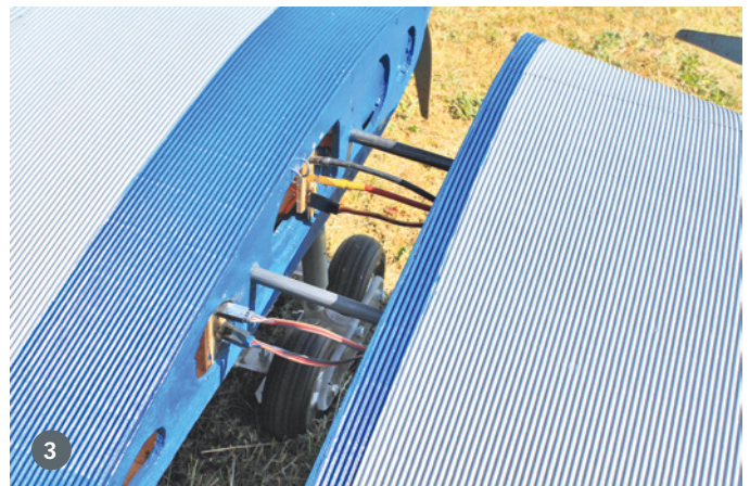
1.) Die in die Fläche voll integrierten Motorgondeln sind so üppig, dass Antriebe dort spielend Platz finden. 2.) Trapezflügel waren in den 1930er-Jahren durchaus verbreitet, man denke nur an die Entwürfe von De Havilland. Die über die ganze Fläche verteilten, abgesetzten Klappen sind ebenfalls auffällig. 3.) Flächensteckung des Außenflügels über 12-mm-Stahl- und Kohlestäbe. Außerdem die Kabel für den äußeren Motor und Servosteckungen für das Querruder und die mittlere Klappe
