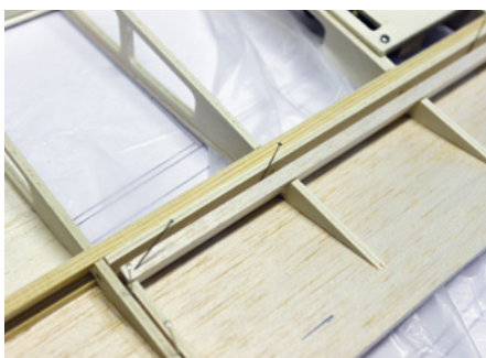
Der Querruderholm beziehungsweise -anschlag ist schräg eingesetzt, um nichts vom Material abtragen zu müssen
