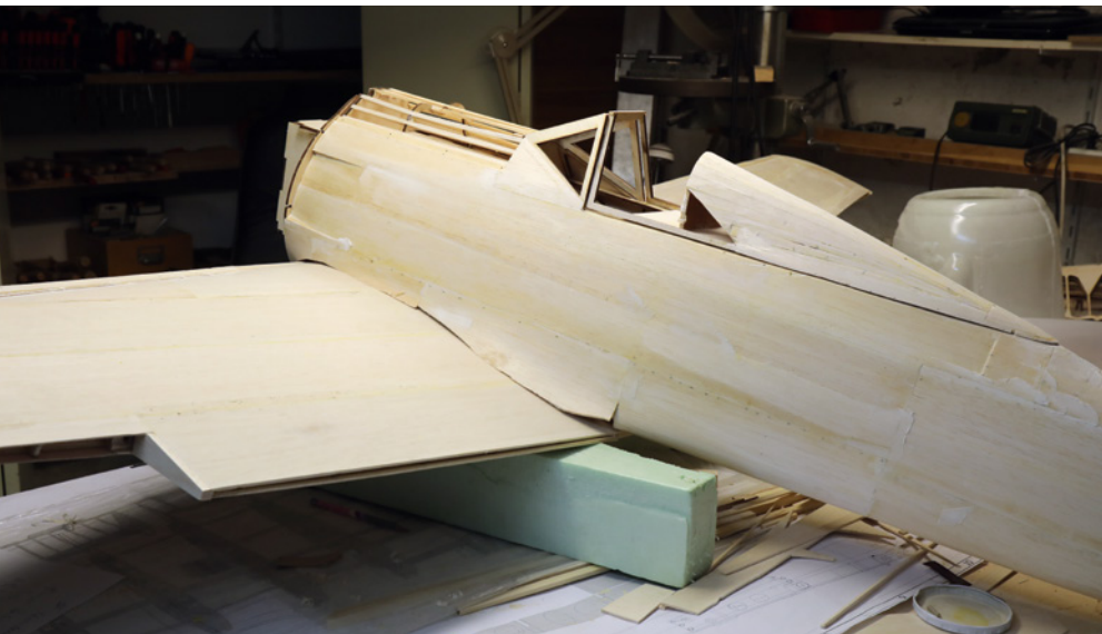
1.) Nach dem Aushärten des konventionellen Holzleims an der Stoß-auf-Stoß-Beplankung hat sich eine Planke „aufgeworfen“. Das ist eigentlich wichtiges Material, dass nun dem anschließenden Schleifen zum Opfer fällt
