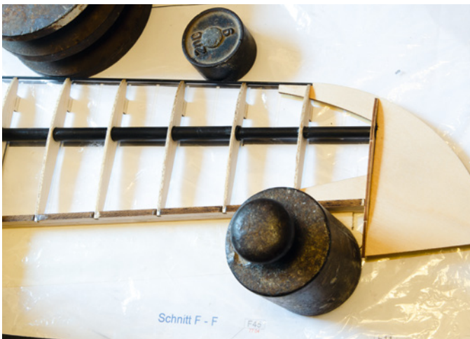
Beim Verkleben von Nasen- und Querruderanslagleiste des Tragflächenendteils helfen Gewichte. Die 3D-Darstellung im Bauplan macht die Montage einfach
