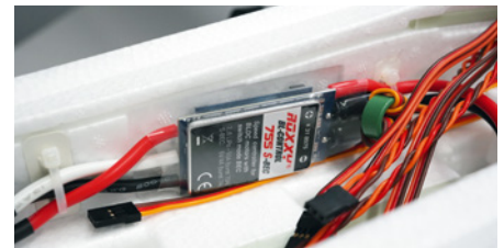
Bis zu 55 A Belastung verträgt der ab Werk verbaute Brushless-Regler und ist passend dimensioniert
