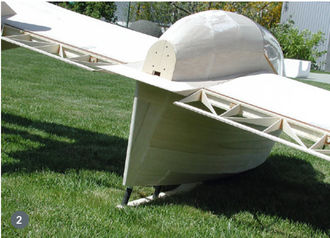
1) Kolossaler Rohbau fertig zum Bespannen – auch das kostete einiges an Zeit. 2) Zwischen beiden Seitenleitwerken sind die Höhenruderrhälften eingesetzt. 3) Das gelb-weiße Finish ist durchaus klassisch für die Fauvel
