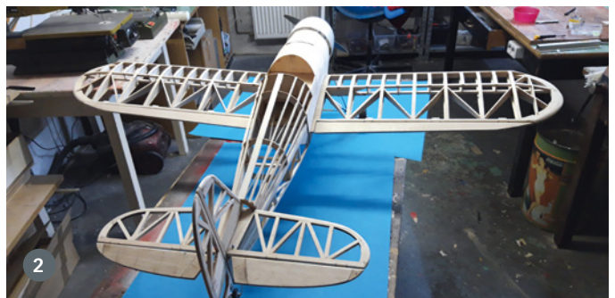
1) Eine große Montagehilfe sind selbst erstellte Hellingwinkel. Mit ihnen ist eine exakte Fixierung möglich. 2) Fertig montiert und bereit zum Bespannen mit Proficover 2 von Practical Scale
