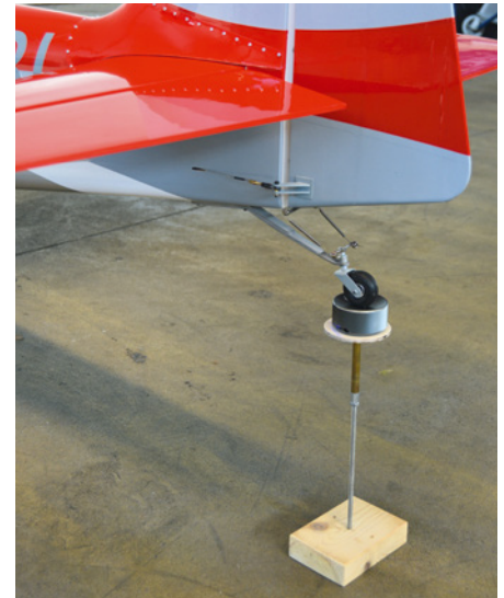
Mit dieser einfachen, höhenverstellbaren Vorrichtung lassen sich auch große Flugmodelle genau um die Querachse ausrichten
