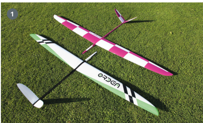
1) Im Vergleich mit einem seiner Vorgänger, dem Rotmilan. Der Orden ist etwas kleiner, die Ruder laufen bis nach außen zum Randbogen und insgesamt sind die Grundrisse von Tragfläche und Leitwerk etwas mehr abgerundet. 2) Beim Auskreisen von Thermik zeigt sich das Modell von seiner besten Seite und zeigt eine gute Steigleistung
