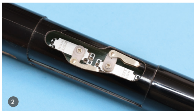
1) Der Regler wird auf kürzestem Weg mit dem Motor verbunden und dann nach vorne geschoben. Viel größer dürfte der Regler allerdings nicht sein. 2) Hier die Rumpfservos mit den fertiggestellten Anlenkungen für das V-Leitwerk. Die Aussparungen in der Rumpfunterseite wurden nachträglich ein wenig vergrößert, um die Anlenkungen zu realisieren
