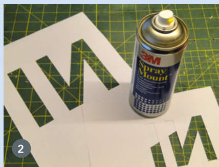
1) Die Kennungen werden zunächst auf DIN A4-Papier ausgedruckt und dann sorgfältig mit einem scharfen Cutter ausgeschnitten. 2) Die Rückseite der Ausdrucke wird mit 3M Montagekleber dünn besprüht. 3) Dann werden die Ausdrucke auf die Modell-Oberfläche geklebt und dienen so als Schablonen für den Farbauftrag – das Ganze ist mehrfach verwendbar
