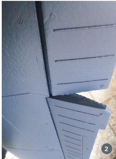
1) Kleines Problem: Am rechten Flügel verkleben sich die Klappen mit dem Querruder. 2) Kurzerhand wurde das Querruder minimal mit dem Cutter gekürzt und die Schnittfläche farblich angeglichen
