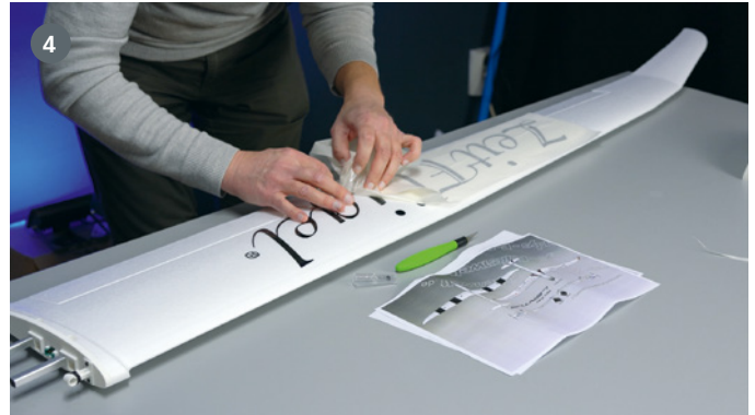
1) Im Lentus geht es eng zu, da hilft es, wenn man die Bugradstellung beim Einsetzen immer etwas anpasst. 2) Im Sender wurde eine Verzögerung zum Ein-/Ausfahren von je einer Sekunde programmiert. 3) Einen hochwertigen Dekorsatz im „Zeitflügel“-Design bietet Andys Folienwelt an. 4) Hilfreich beim Platzieren der Klebefolie sind die mitgelieferten DIN A4-Ausdrucke. Das Ankleben der Schriftzüge erfolgt mit Geduld und Vorsicht
