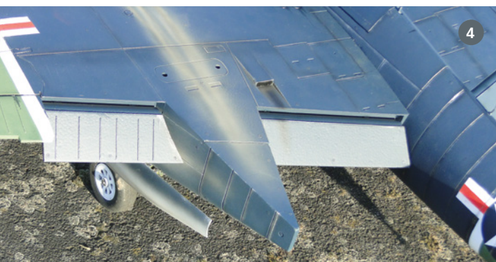
1) Alle Abgasspuren entstanden mit der Airbrush, allerdings in einem eher hellen statt dunklem Farbton. 2) Vorsicht bei Sonne: Nur zehn Minuten direkte Sonneneinstrahlung im März(!) führten zu dieser Blasenbildung an der Oberfläche. Je dunkler die Lackierung, desto schneller tritt der Effekt auf. Also nach dem Flug das Modell schnell in den Schatten stellen. 3) Die Fahrwerksklappen werden mittels dieser Spiralfeder betätigt. Wirkt sehr rustikal, funktioniert aber tadellos. 4) Beim Gestalten von Ölsuren sollte man sich an Abbildungen von Originalen orientieren, die man im Internet findet. 5) Die F7F Tigercat von Freewing/Hepf war 2021 das mit knapp 100 Einsätzen am häufigsten von mir geflogene Modell
