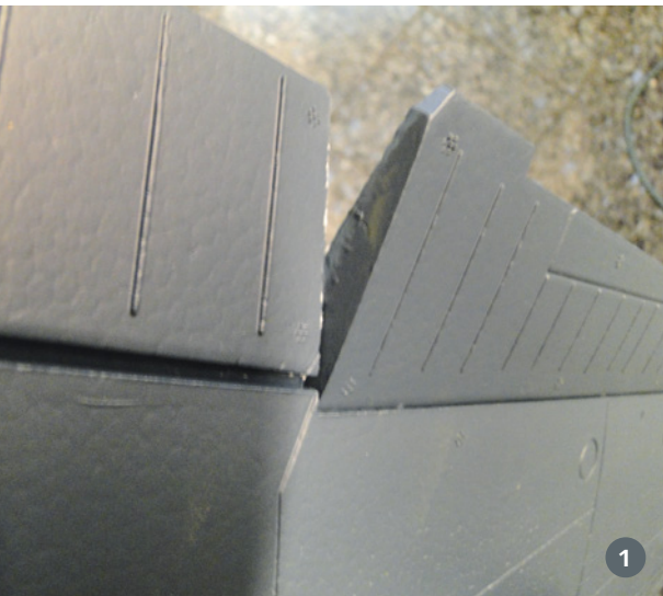
1) Kleines Problem: Am rechten Flügel verkleben sich die Klappen mit dem Querruder. 2) Kurzerhand wurde das Querruder minimal mit dem Cutter gekürzt und die Schnittfläche farblich angeglichen
