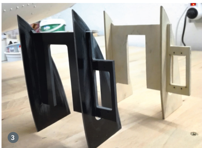
1) Die Aufnahme für das Bugfahrwerk wird am Rand des Ausschnitts verklebt. 2) Die große Motorhaube kann komplett abgenommen werden, was den Zugang zur Antriebstechnik leicht macht. 3) Im Bausatz ist für die Aufnahme des Bugfahrwerks eine Holzkonstruktion enthalten. Walter Keller tauschte sie aber gegen eine mit CFK-Laminat. 4) Hier das elektrische Bugfahrwerk mit montiertem Scheinwerfer im eingefahrenen Zustand. Die Fahrwerkstüren wurden ebenfalls mit ABS-Innenverkleidungen aufgedoppelt. Das Bild entstand nach dem Flug auf nasser Landebahn, daher die Verschmutzungen an Rumpf und Fahrwerk
