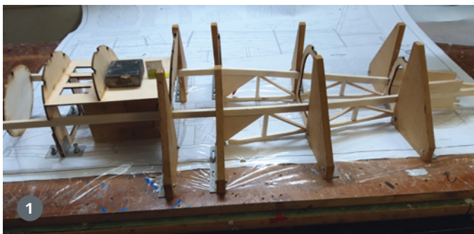
1) Eine große Montagehilfe sind selbst erstellte Hellingwinkel. Mit ihnen ist eine exakte Fixierung möglich. 2) Fertig montiert und bereit zum Bespannen mit Proficover 2 von Practical Scale
