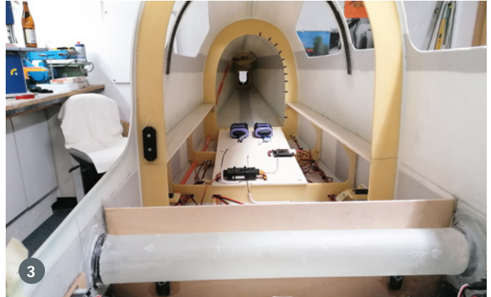
1) Hier das Antriebspaket vor dem Einbau: Koenig 100 Boxer mit Heckansaugung, Alu-Krümmter und -Dämpfer von MJM (James Metternich) und der Engel Dreiblatt-Propeller. 2) Die Fenster einzukleben erfordert Geduld und sauberes Arbeiten. Walter Keller verwendet hierfür den Bau-Montagekleber von Fishbull, den es aber nur in Weiß gibt. 3) Im Rumpf ist reichlich Platz für die erforderlichen Einbauten. Die Aufnahme für die Steckung und die beiden Spanten sind bereits ab Werk installiert. Walter hat die dazwischen liegenden Fensterholme noch mit CFK-Roving verstärkt
