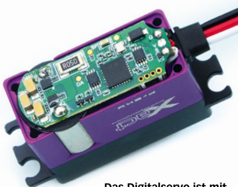
Das Digitalservo ist mit hochwertigen Bauteilen und direkt angelötetem Motor ausgestattet
