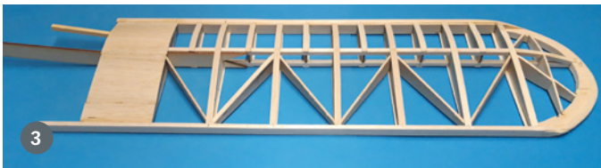
1) Plan, Holzbauteile und tiefgezogene Motorhaube bekommt man bei Sarik Hobbies aus England. 2) Die Konstruktion ist klassisch umgesetzt, beispielsweise erfolgt der Aufbau von Leitwerken und Rudern mit Stegen. 3) Alle Voll- und Halbrippen erhalten Aufleimer, sodass mehr Fläche fürs spätere Bebügeln vorhanden ist. 4) Ein Teile des vorderen Rumpfbereichs. Die gelaserten Teile sind von sehr guter Qualität. 5) Beide Hauptseitenteile entstanden parallel, damit sie auch garantiert deckungsgleich sind
