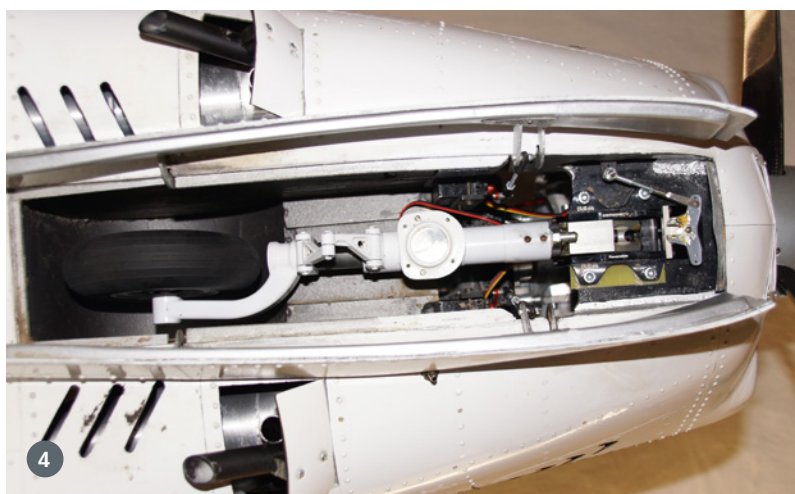
1) Die Aufnahme für das Bugfahrwerk wird am Rand des Ausschnitts verklebt. 2) Die große Motorhaube kann komplett abgenommen werden, was den Zugang zur Antriebstechnik leicht macht. 3) Im Bausatz ist für die Aufnahme des Bugfahrwerks eine Holzkonstruktion enthalten. Walter Keller tauschte sie aber gegen eine mit CFK-Laminat. 4) Hier das elektrische Bugfahrwerk mit montiertem Scheinwerfer im eingefahrenen Zustand. Die Fahrwerkstüren wurden ebenfalls mit ABS-Innenverkleidungen aufgedoppelt. Das Bild entstand nach dem Flug auf nasser Landebahn, daher die Verschmutzungen an Rumpf und Fahrwerk
