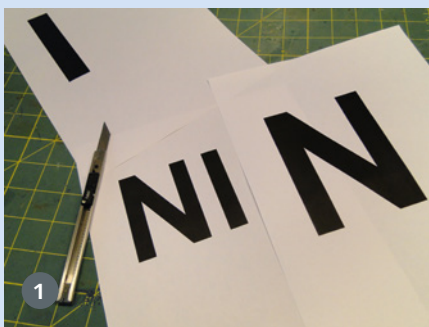
1) Die Kennungen werden zunächst auf DIN A4-Papier ausgedruckt und dann sorgfältig mit einem scharfen Cutter ausgeschnitten. 2) Die Rückseite der Ausdrucke wird mit 3M Montagekleber dünn besprüht. 3) Dann werden die Ausdrucke auf die Modell-Oberfläche geklebt und dienen so als Schablonen für den Farbauftrag – das Ganze ist mehrfach verwendbar
