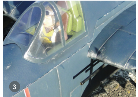
1) Der Fanghaken macht die Tigercat Flugzeugträger-tauglich. Fehlt bloß der maßstäbliche Flugzeugträger. 2) Die mitgelieferten Kanonenrohre sind zu dünn geraten, daher wurden sie mit Schrumpfschlauch aufgefüllt und neu lackiert. 3) Platziert am Modell und mit weiterem Weathering bearbeitet wirkt die Bewaffnung noch authentischer
