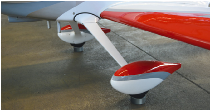
Durch die konvexe Oberflächenform der Waagen stehen die Räder sicher und zentriert
