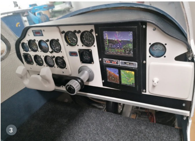
1) Mit der Beechcraft Bonanza von Tomahawk Aviation nahm Walter Keller bereits am Europa Star Cup teil. 2) Aufgrund des Maßstabs 1:2,88 und 3.550 mm Spannweite erweckt die Bonanza einen verblüffenden Scale-Eindruck. 3) Meisterlich gelungenes Cockpit. Allerdings fehlen auf dem Bild noch die Schalter, Knöpfe und andere Scale-Details auf dem „nackten“ Steuerhorn. 4) Bitte einsteigen zum Rundflug
