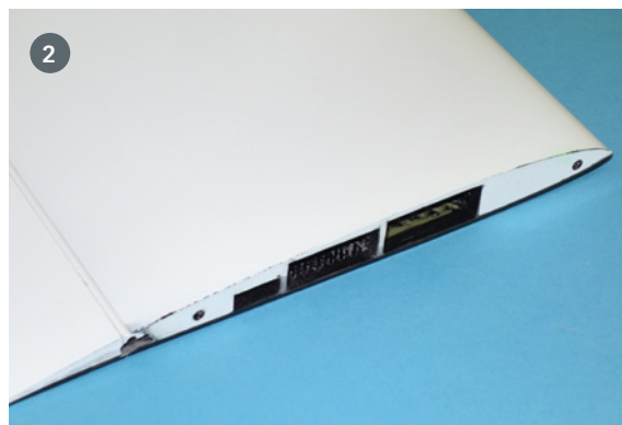
1) Das in die Dichtlippe integrierte IDS-System ist ein Alleinstellungsmerkmal der Modelle von RTG. 2) Hinter dem Flügelverbinder befindet sich ein Ballastschacht. Die Bohrungen für die Torsionsstifte sind ebenfalls schon eingebracht, hier müssen lediglich noch die Stifte eingeklebt werden
