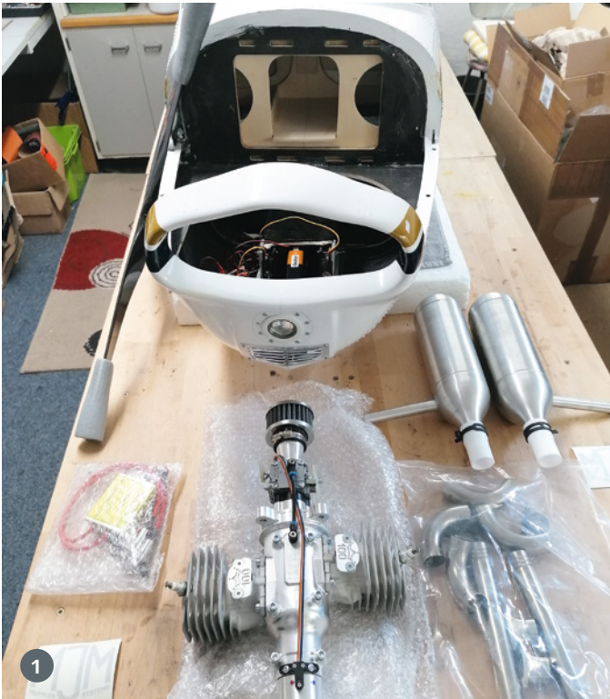
1) Hier das Antriebspaket vor dem Einbau: Koenig 100 Boxer mit Heckansaugung, Alu-Krümmter und -Dämpfer von MJM (James Metternich) und der Engel Dreiblatt-Propeller. 2) Die Fenster einzukleben erfordert Geduld und sauberes Arbeiten. Walter Keller verwendet hierfür den Bau-Montagekleber von Fishbull, den es aber nur in Weiß gibt. 3) Im Rumpf ist reichlich Platz für die erforderlichen Einbauten. Die Aufnahme für die Steckung und die beiden Spanten sind bereits ab Werk installiert. Walter hat die dazwischen liegenden Fensterholme noch mit CFK-Roving verstärkt
