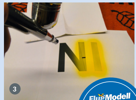
1) Die Kennungen werden zunächst auf DIN A4-Papier ausgedruckt und dann sorgfältig mit einem scharfen Cutter ausgeschnitten. 2) Die Rückseite der Ausdrucke wird mit 3M Montagekleber dünn besprüht. 3) Dann werden die Ausdrucke auf die Modell-Oberfläche geklebt und dienen so als Schablonen für den Farbauftrag – das Ganze ist mehrfach verwendbar
