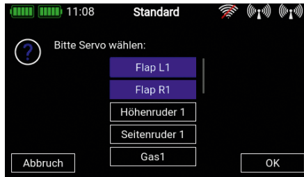
Sollen einer Funktion zusätzliche Servos zugeordnet werden, so zeigt der Sender alle verfügbaren Servos an und die ausgewählten werden dann blau markiert
