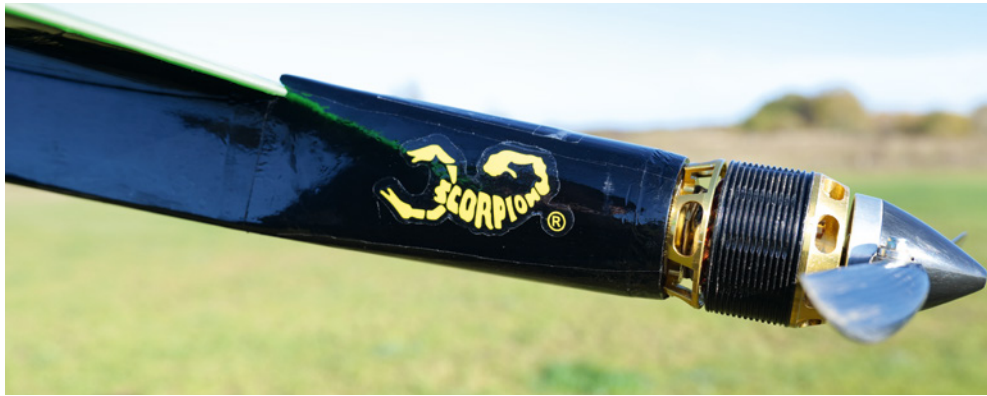
Sieht brachial aus, dient aber mehr der Performance, denn so ist der Motor optimal gekühlt
