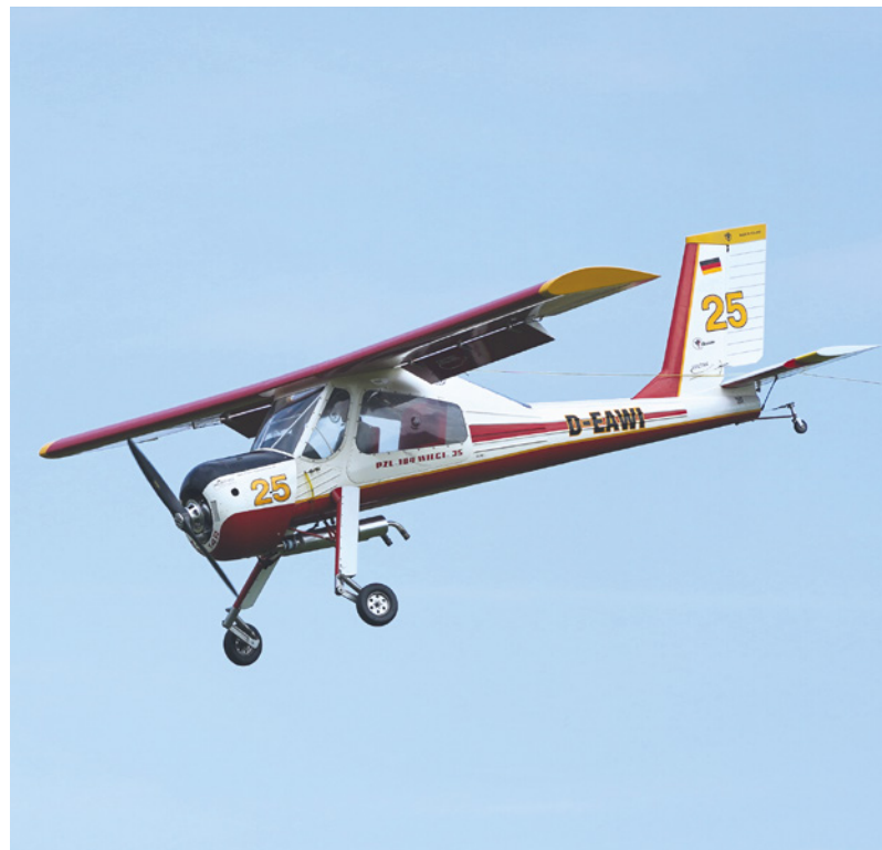
Abbildung 11: Schleppmodelle, wie diese Wilga, haben wirkungsvolle Landeklappen, die die Sinkgeschwindigkeit erhöhen
