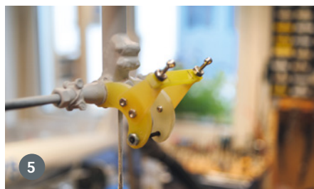
5 Der Schließmechanismus beider Klappen und die Ram Air Turbine sind gekoppelt
