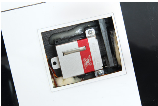
Damit die Servokräfte optimal auf die Ruder übertragen werden, muss der Servorahmen auch mit der Unterschale verklebt werden
