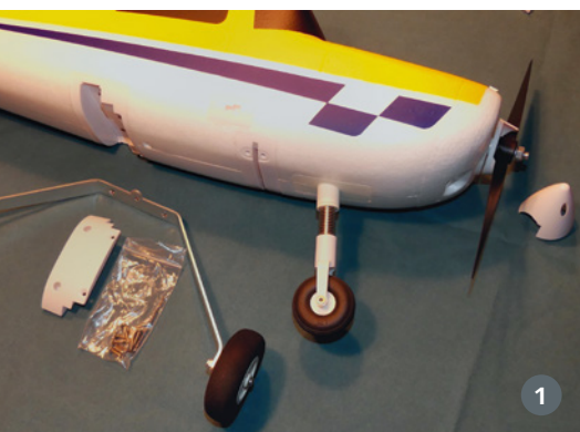
1) Die Räder des Hauptfahrwerks sind bereits am robusten Fahrwerksbügel vormontiert. 2+3) Der Fahrwerksbügel ist vorgebohrt und wird zusammen mit der Kunststoffabdeckung am Rumpf verschraubt. Dabei sind die kurzen Schrauben für vorne und die langen für hinten gedacht
