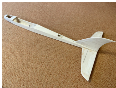
Die Leitwerke sind eingeklebt und vorne Rumpf ist eine Zugangsklappe eingelassen
