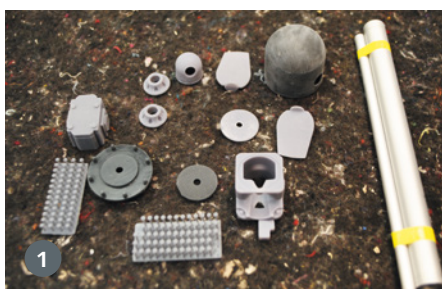
1 Aus einer Reihe 3D-Druck-Teilen ist die Ram Air Turbine zusammenzubauen
