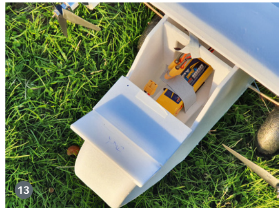
Große Klappe: So lässt sich der Akku leicht wechseln. Tape dient hier als Scharnier
