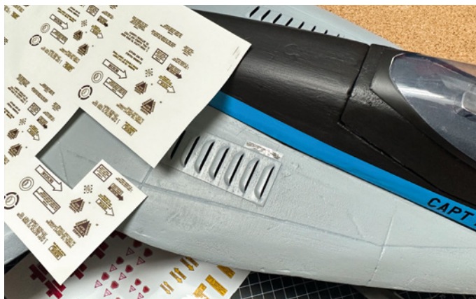
Mit einem Drucker, etwas transparenter Aufkleberfolie und ein paar Vorlagen lassen sich spielend leicht Wartungsbeschriftungen erstellen
