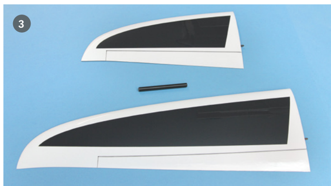
3) Hier die beiden Außenohren im Größenvergleich. Die Ruder werden mit Klebeband mit den Querrudern vom Hauptflügel verbunden. 4) Im Zubehör mit dabei ist sogar ein Ballastset, womit sich die Flächenbelastung von zirka 40 auf 50 g/dm 2 erhöhen lässt
