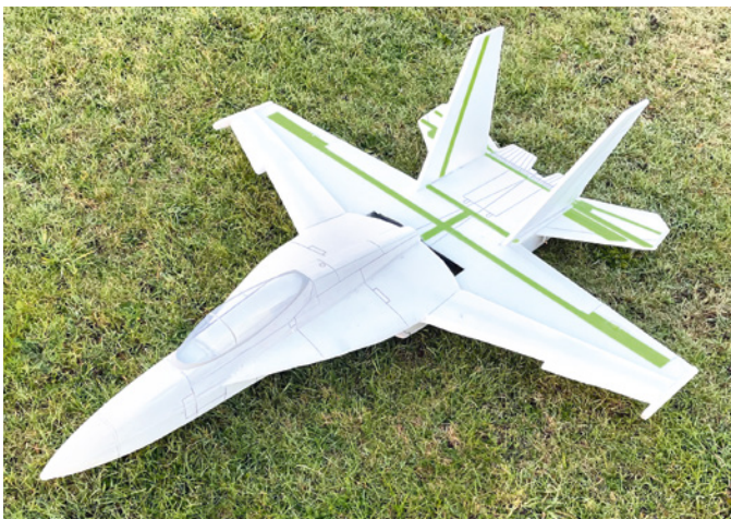
Die fertige F/A-18E unmittelbar vor ihrem ersten Flug. Parkettlack und Panellines sind bereits angebracht, alle weiteren Schritte folgen aber erst, wenn sich das Modell in der Luft bewährt hat
