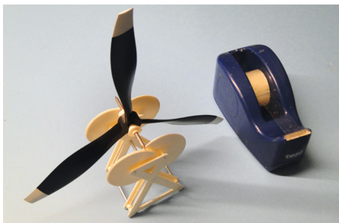
Das Auswuchten der Luftschraube lohnt sich! Tesafilm dient dabei als Trimmgewicht
