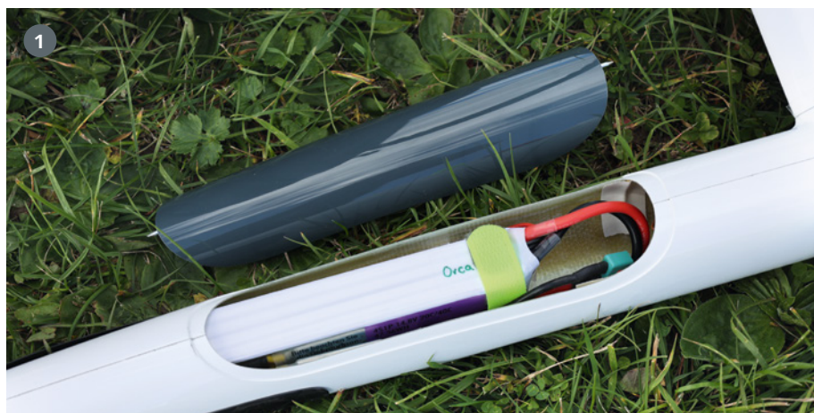
1) Der Antriebsakku wird soweit wie möglich nach vorne geschoben, um auf Trimblei verzichten zu können. 2) Ein längerer Leitwerkshebelarm und größere Leitwerksflächen verbessern beim Orca-proX das Handling gegenüber dem Vorgänger
