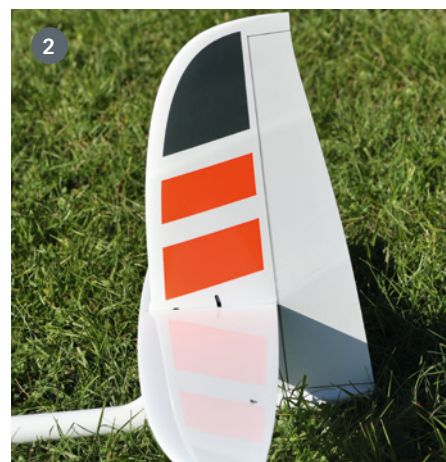
1) Der Antriebsakku wird soweit wie möglich nach vorne geschoben, um auf Trimblei verzichten zu können. 2) Ein längerer Leitwerkshebelarm und größere Leitwerksflächen verbessern beim Orca-proX das Handling gegenüber dem Vorgänger
