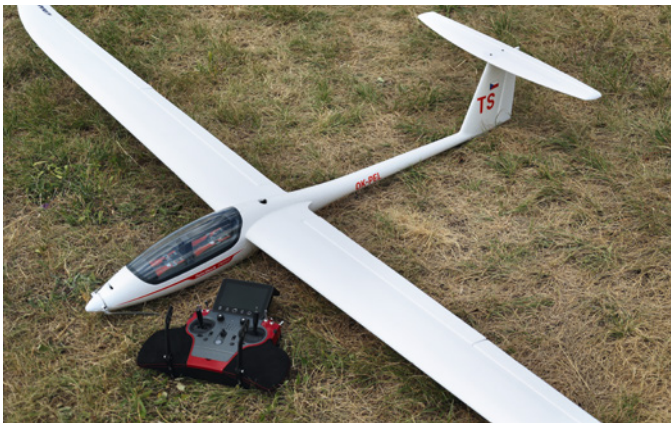
Die ersten Flüge fanden mit dem Twin Shark von Kavan statt. Durch seinen Vierklappenflügel konnten relativ viele Funktionen ausprobiert werden
