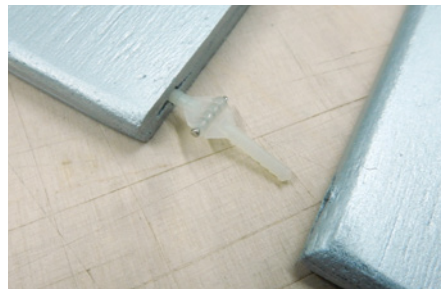
Stiftscharniere am Leitwerk sind eine robuste und praxistaugliche Lösung
