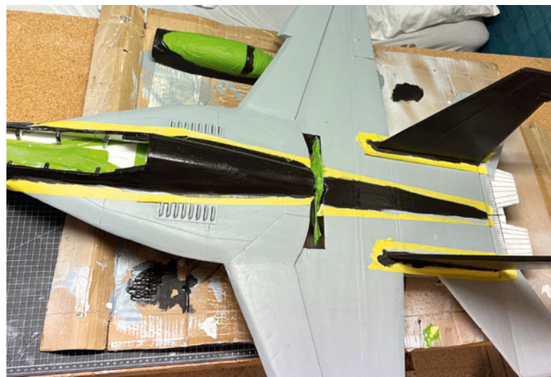
Neben dem grauen Grundanstrich wurden Rumpfrücken und Seitenleitwerke in Schwarz lackiert. Für eine saubere Farbkante sollten die Ränder zum Klebeband unbedingt mit der grauen Farbe vorgestrichen werden, ansonsten läuft die schwarze Farbe garantiert unter das Klebeband und bildet Laufnasen
