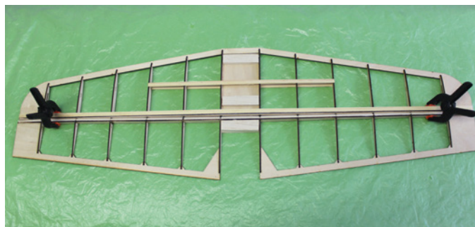
Zur Beplankung bereites Leitwerk. Aktuell werden die Holzteile für das Hohlkehlscharnier fixiert
