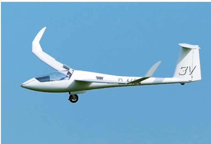
Abbildung 10: Der Ventus 3 ist ein Sechs-Klappen-Segler. Die Wölbung seiner Tragfläche kann damit entlang der Spannweite in drei Schritten beeinflusst werden. Hier sind sogar Störklappen aktiv
