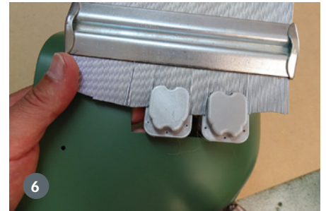
Eine Konturenlehre erfasst die nötigen Ausschnitte für die Leitbleche
