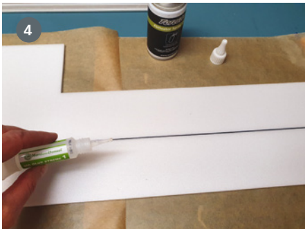
4 Mit depronverträglichem Sekundenkleber wird der Holm eingesetzt. Mit Backpapier wird verhindert, den Flügel versehentlich am Baubrett festzukleben
