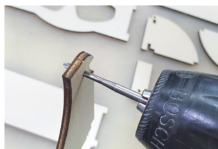
Die Anzahl der Einzelteile ist überschaubar - sie wurden mit dem Mr Beam Laserschneider hergestellt. Alternativ zeigt der Bauplan aber auch eine simplere Version ohne Verzahnungen
