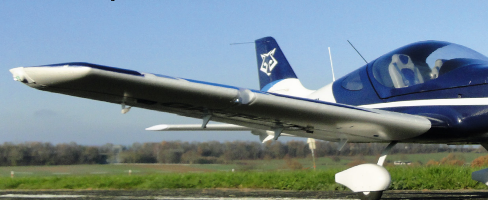
Das stabile Hauptfahrwerk aus Alu wird mit dem Flügel verschraubt
