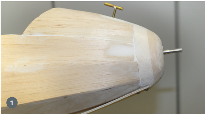
1) Obwohl der Rumpf weitgehend kantig ist, muss die Nase verrundet werden. Das geht mit Balsa am besten.
