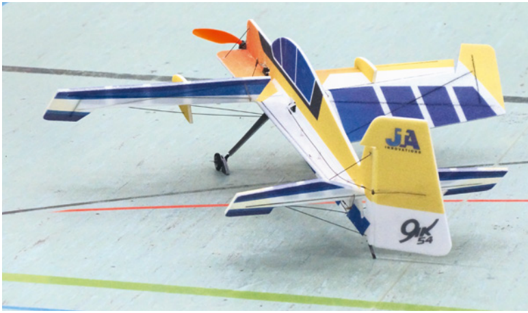
Abbildung 1: Geradezu prädestiniert für Flugfiguren mit wenig Auftrieb sind Indoor-Kunstflugmodelle – auch darum die großen Klappen
