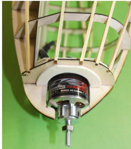
In klassischer Spantenbauweise mit Gurten entsteht das zweiteilige Rumpfergüst. Hier nimmt der Motor probeweise Platz
