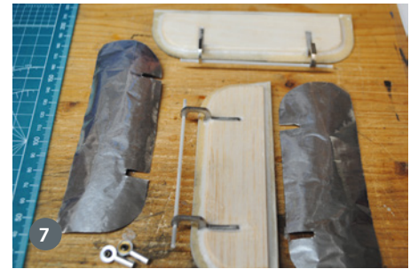
Grundlage der Deckel sind die ausgesägten Teile, unterfüttert mit Balsa und versehen mit Scharnieren
