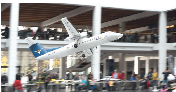
Abbildung 5a: Im Modell der Dash 8 sind Fowler-Flaps verbaut, um langsames Indoorfliegen zu ermöglichen
