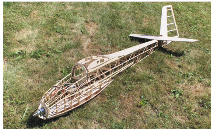
Weitgehend fertiggestellter Rumpf. Aktuell wird die abnehmbare Kabinenhaube eingepasst
