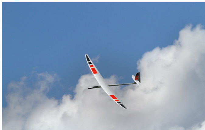
Durch die leichte Mehrfach-V-Form und die neue Leitwerksauslegung kreist der Orca-proX sehr schön und gewinnt zügig an Höhe
