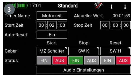
1) Der Funktionsumfang der Atom wird in unterschiedlichen Kacheln strukturiert. 2) Es lassen sich auch Telemetrie-Sensoren von Fremdherstellern an den P 2 -Bus anschließen. Hier wurde ein SM MicroVario als Sensor erkannt. Rechts daneben werden die jeweils verfügbaren Telemetriewerte zu jedem Sensor angezeigt. 3) Hier wurde ein Motor-Timer realisiert, der erst rückwärts zu zählen beginnt, wenn sowohl der Gas-Schalter, als auch der Gas-Not-Aus-Schalter in der richtigen Stellung stehen
