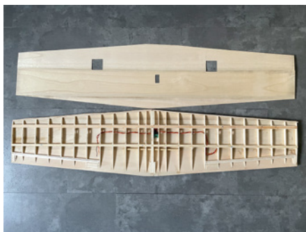
Vorbereitung zur Beplankung der Unterseite des Flügels. Statt Balsa kam festeres Palowniahholz zum Einsatz
