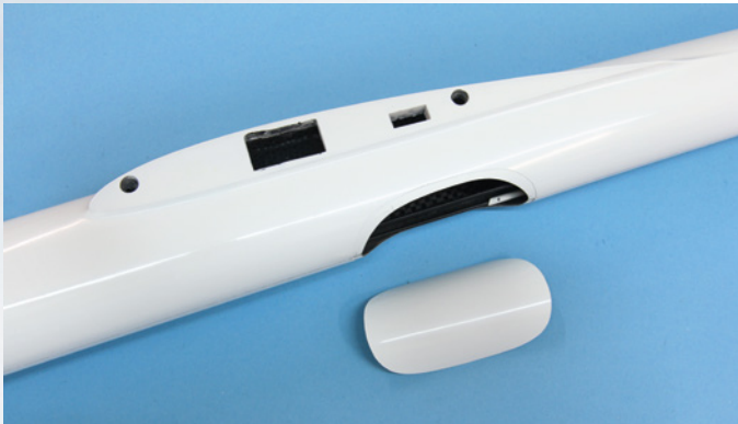
Unterhalb der Tragfläche befindet sich eine Rumpfflappe, dort können die Rumpfservos eingebaut werden
