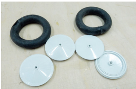
Die Reifen entstehen aus 12-mm-Moosgummischnur, die in einer Pappschablone verklebt wird, und zweiteiligen Kunststoffnaben aus Spritzguss
