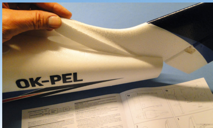
Die Öffnung für die Aufnahme des Seitenruders ist etwas zu breit, deshalb wurde zur Befestigung ein spaltfüllender Kleber verwendet
