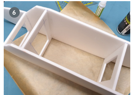
6 Schon nach kurzer Zeit steht ein stabiler Kastenrumpf auf dem Baubrett
