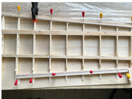
Ankleben der Hilfsnasenleisten und Einbau beziehungsweise Verkasten der Querruder
