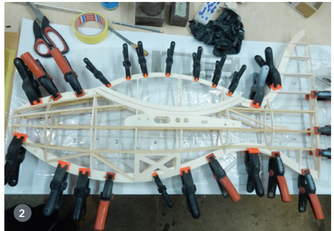
1) Die beiden Rumpfhälften werden zunächst separat aufgebaut. 2) Mit Hilfe von Positionierstiften, Weißleim und vielen Klammern lassen sich beide Rumpfhälfte zu einem eleganten Rumpferippe zusammenfügen
