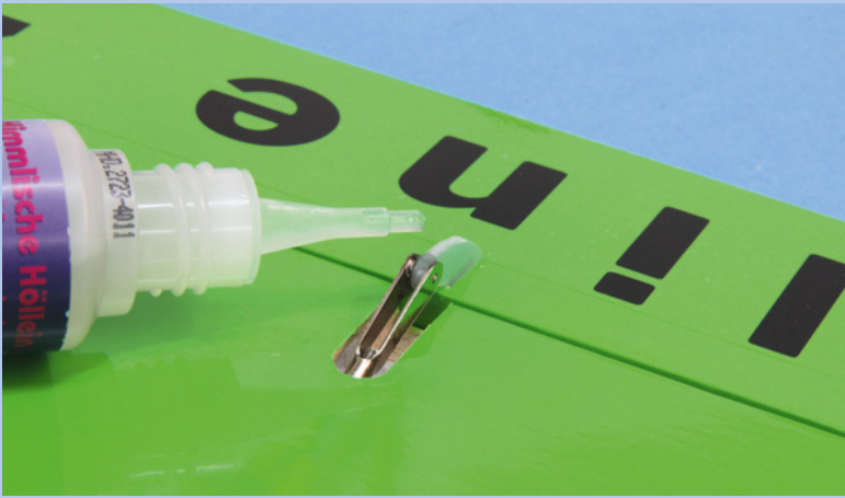
Leider waren die Bohrungen in den GFK-Ruderhörnern etwas zu groß für die mitgelieferten Gabelköpfe. Daher wurde die Bohrung mit einem Tropfen dünnflüssigem Sekundenkleber angepasst und wieder gängig gemacht
