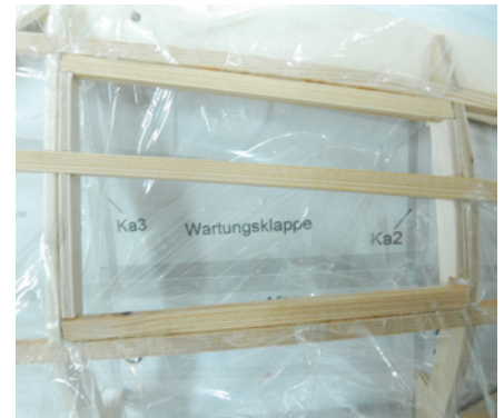
Besonders praktisch ist die Inspektionsklappe auf der rechten Seite
