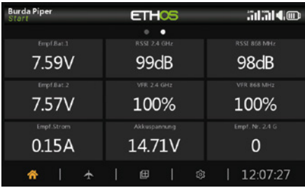
So können die Telemetriedaten des Empfängers auf einer Displayseite dargestellt werden
