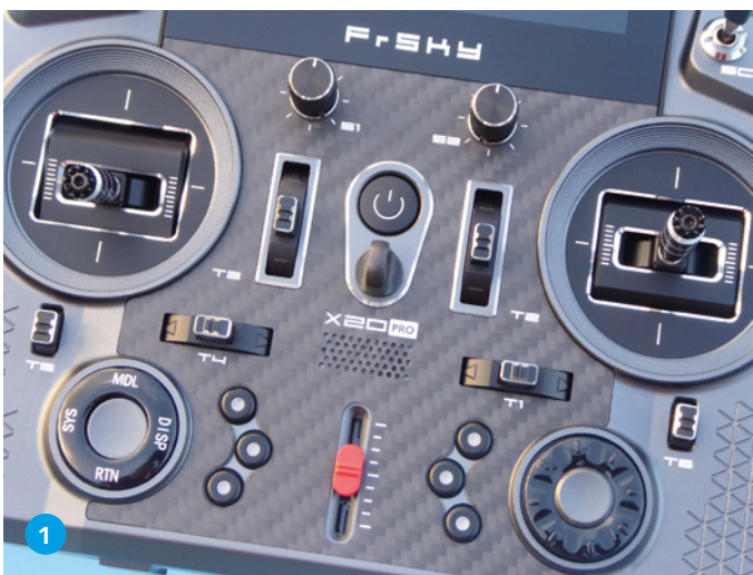
1) Mittig befindet sich der Ein-aus-Schalter, darüber sind zwei Dreh- und seitlich darunter zwei Tastgeber angebracht, unten sind ein Schiebekanal und sechs individuell belegbare Tasten vorhanden. 2) Besser kann man ein Display nicht anordnen, es ist auch bei Sonnenlicht gut ablesbar.
