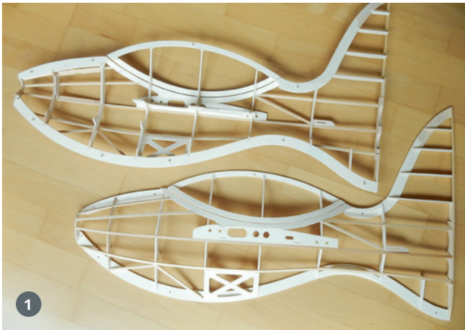
1) Die beiden Rumpfhälften werden zunächst separat aufgebaut. 2) Mit Hilfe von Positionierstiften, Weißleim und vielen Klammern lassen sich beide Rumpfhälfte zu einem eleganten Rumpferippe zusammenfügen
