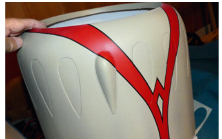
Die Sternattrappe wurde in Höhe des DLE-Zylinderkopfs großzügig von den Kunststoffzylindern befreit, um im Einsatz die Kühlluft frei strömen zu lassen
