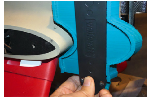
Die Tragflächen-Anformungen des Rumpfs ragen einige Zentimeter rechts und links in die Motorhaube. Mithilfe einer Konturenlehre kann man die Form abnehmen und auf die Motorhaube übertragen. Die erforderliche Tiefe der Ausschnitte wird erst nach der Montage des Motors ermittelt
