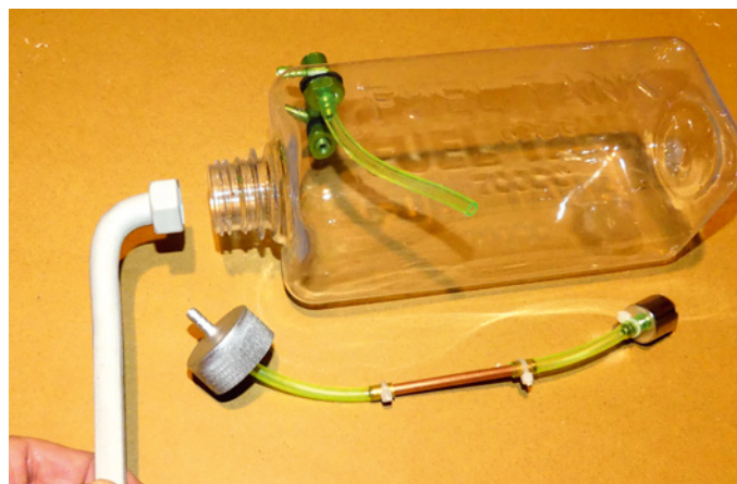
Um beim Verschrauben der Tanknippel die Muttern im Tankinneren gegenhalten zu können, ist ein Kunststoff-Speziälschlüssel im Lieferumfang enthalten. Das teilweise hohle Innere des Schlüssels ist bewusst so gestaltet, denn so kann man die Mutter anziehen, obwohl am Nippel bereits der Schlauch montiert ist. Einfach den Schlüssel über den Schlauch zur Mutter führen und den Tanknippel von außen festziehen – fertig
