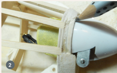
1) Rund um den Motorspant wird mit Balsaresten aufgefüllt. Um den Übergang zum Spinner sauber hinzubekommen, wird der Motor mit Klebeband vor Schleifstaub geschützt und eingebaut. 2) Mit Hilfe des Spinners wird angezeichnet, wie weit geschliffen werden muss. 3) Nach dem Schleifen sieht das dann so aus – nicht so elegant wie ohne Motor, aber irgendwie auch reizvoll
