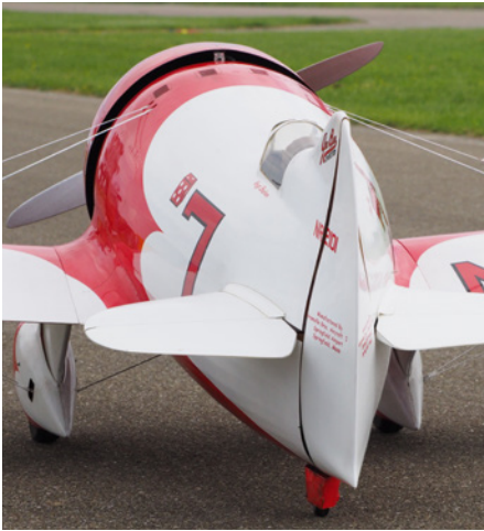
Abbildung 11: Als Paradebeispiel für wenig Propeller und viel Rumpf könnte die GeeBee R1 gelten, doch der Prop hat genug Platz, dank abgerundeter Cowling
