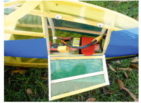
Über die Klappe am Bug hat man Zugang zum Flugakku, der am vordersten Spant anliegt und mit einer Klettschleufe gesichert ist
