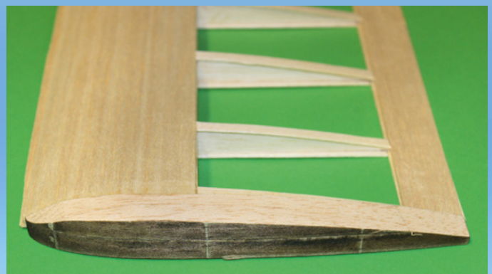
Massiver Randbogen aus zwei 10-mm-Balsateilen. Außerdem erkennbar sind die nachträglich montierten Rippenaufleimer
