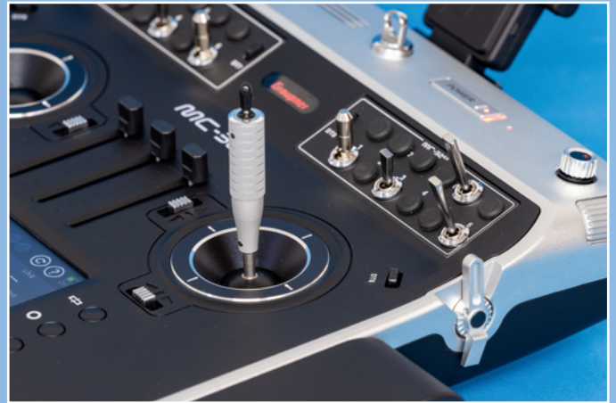
Kuggelagerter und mit Hallsensoren sowie Schalter ausgebauter Aluknüppel
