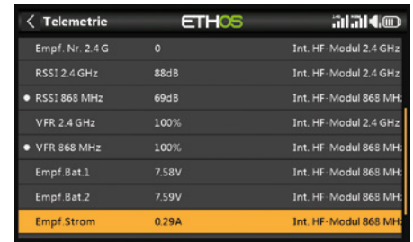
Die Spannungen beider Akkus des Tandem-Empfängers sowie dessen Stromaufnahme lassen sich per Telemetrie überwachen
