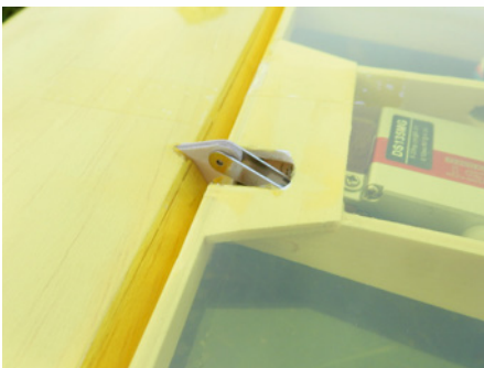
Die Ruderhörner greifen tief in die Klappen ein und werden direkt über Kreuz spielfrei angelenkt
