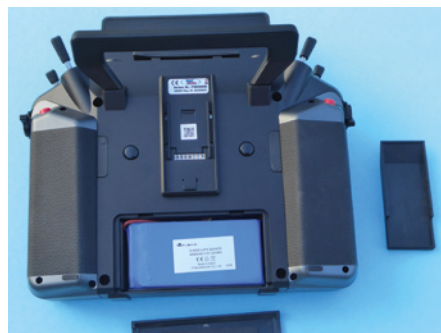
Rückseitig sind das Akkufach und ein Schacht für ein externes HF-Modul untergebracht, gut erkennbar sind die beiden rückseitigen Tasten
