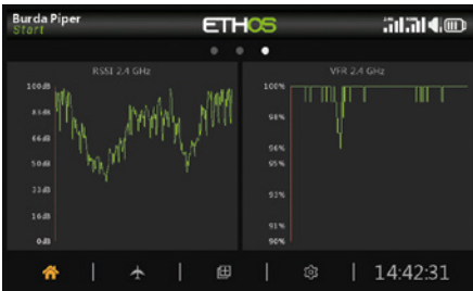
Zur Überprüfung der Funkstrecken lassen sich Liniendiagramme der Kennwerte generieren
