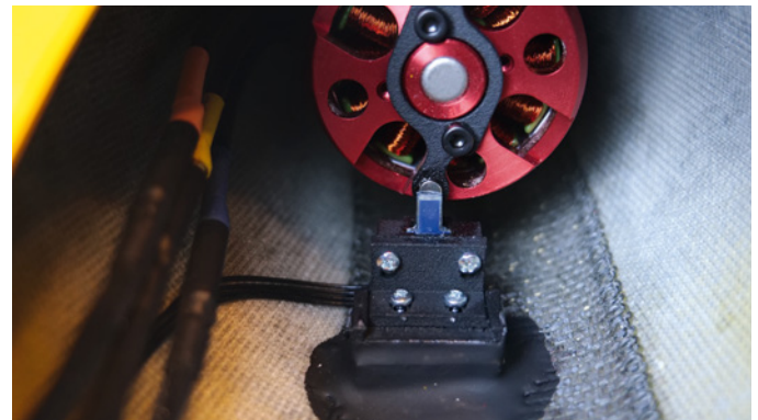
Betriebsbereit eingebaute Sensorik. Die Positionierung der Propellerblätter erfolgt über die Glocke des Außenläufers
