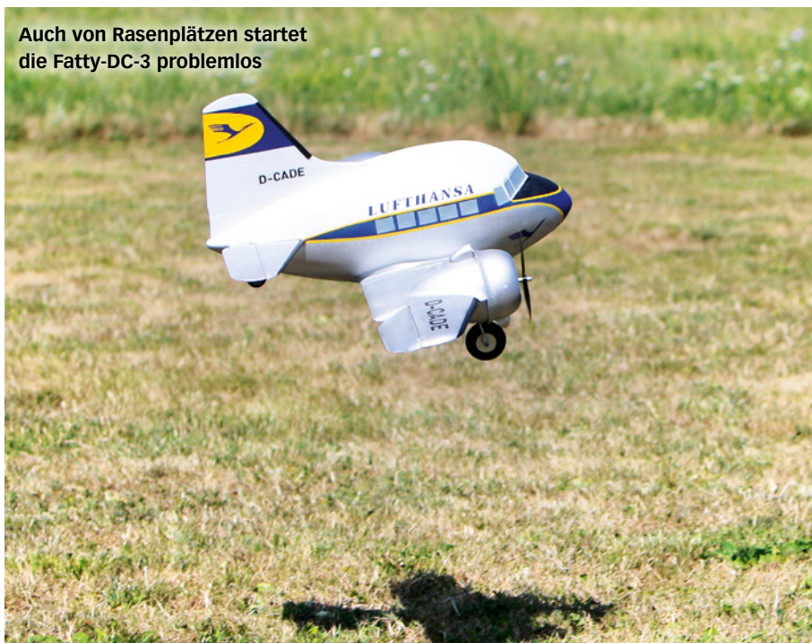
Die Leichträder von robbe sind noch zu schwer. Aus dem Grund wurden die Plastikfelgen weggelassen
