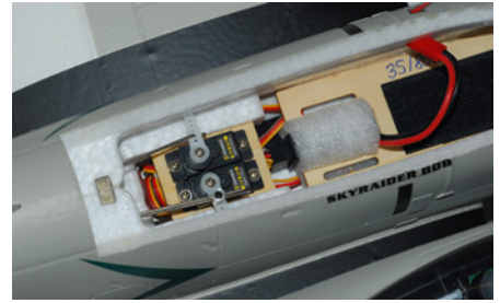
In etwas Schaumstoff gehüllt und sanft eingequetscht ist der Empfänger platziert
