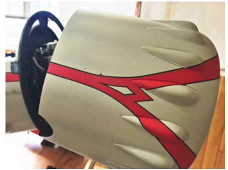
Die Motorhaube passt nur über den Ringspann des Rumpfs, wenn man sie schräg entsprechend dem Foto aufsetzt. Beim Verbrenner ist die Richtung von unten wichtig, da bei der Montage von oben eventuell die Auspuffrohre stören würden
