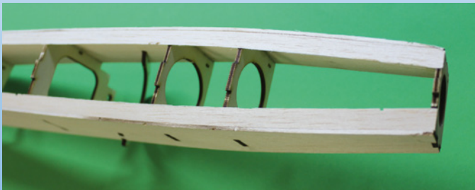
Aus Spanten, Dreiecksleisten und einer Innenbeplankung setzt sich das Rumpfundgerüst zusammen
