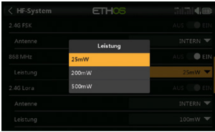
Im TD-Modus kann die Leistung für die 868-MHz-Funkstrecke eingestellt werden
