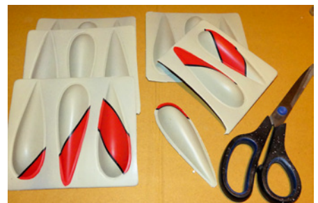
Die Motorhaube wird ohne angeformte Ventil-Hutzen geliefert. Diese müssen erst aus einer Platte ausgeschnitten und in den vertieft angelegten Positionen der Haube verklebt werden
