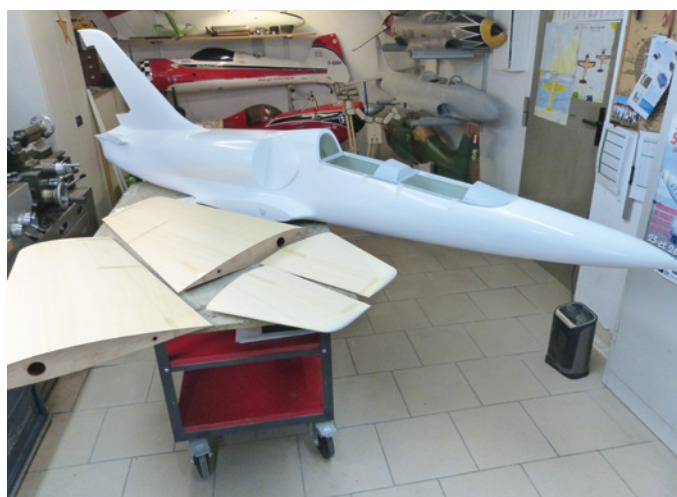
GFK-Rumpf und klassische Styro-Abachi-Flügel sowie Leitwerke kennzeichnen den Bausatz – da bleibt noch viel zu tun
