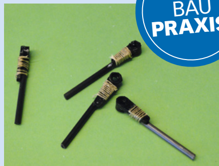
Die Fahrwerksbeine bestehen aus Kohlefaserstangen und Servohebeln, verbunden mit Aramidseil und Sekundenkleber
