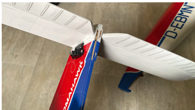
Zwei Servos an exponierter Stelle, das könnte man herstellerseitig auch eleganter lösen
