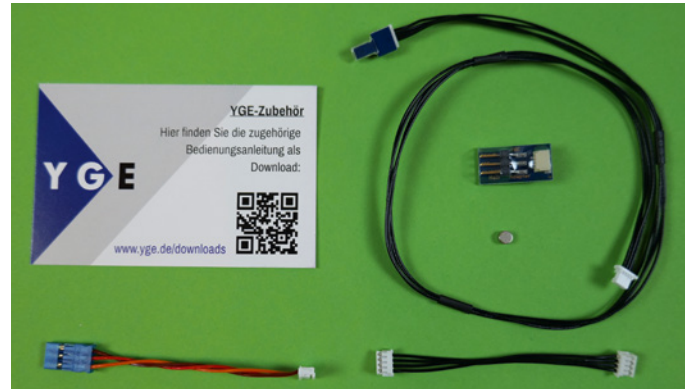
Im Sensor-Kit von YGE sind Magnet, Sensor, Elektronik und konfektionierte Kabel einbaubereit enthalten
