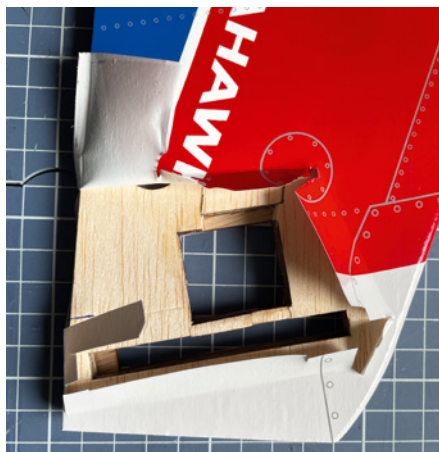
Zur Aufnahme von Servo und Höhenleitwerk ist im Seitenleitwerk beidseitig vorsichtig die Folie anzuheben und die Aufdoppelung einzukleben – wie umständlich!
