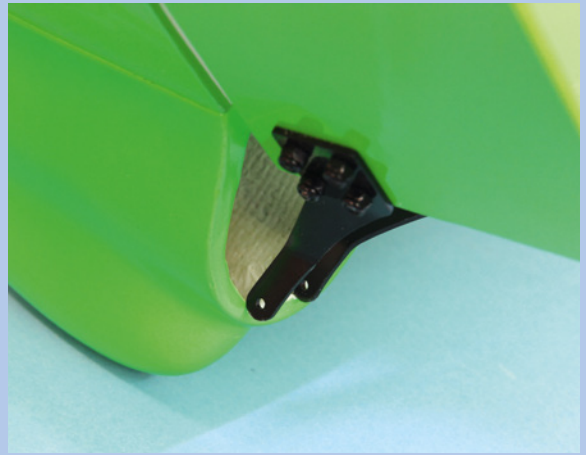
Die Ruderhörner des V-Leitwerks stoßen am hinteren Rand des Rumpfs an. Mit der Feile oder einem Fräser muss die Breite des Rands angepasst werden
