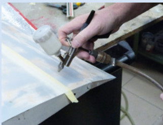
Da der GFK-Rumpf bereits mit Nieten und Beplankungsstößen versehen war, sollten auch welche auf den Flächen und Leitwerken erkennbar sein und waren nachträglich aufzubringen
