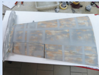
Stöße lassen sich mit Malerkrepp sowie Grundierfüller erstellen und Nieten gelingen sehr gut mit einem Gravierstichel sowie Dremel
