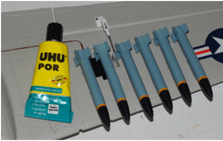
Uhu Por eignet sich sehr gut zum Befestigen der Raketen an der Fläche
