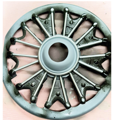
Die Sternattrappe wurde in Höhe des DLE-Zylinderkopfs großzügig von den Kunststoffzylindern befreit, um im Einsatz die Kühlluft frei strömen zu lassen
