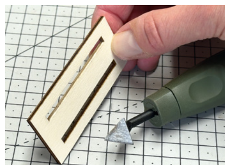
Ein Beispiel von vielen wäre das Entfernen von Laserabbrand an schwer zugänglichen Stellen
