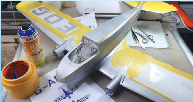
Jetzt musste viel abgeklebt werden: Sämtliche Kennungen und Zierstreifen. Bloß nichts übersehen, und kein Vertun, sonst gibt es nach dem Blaumachen kein Zurück
