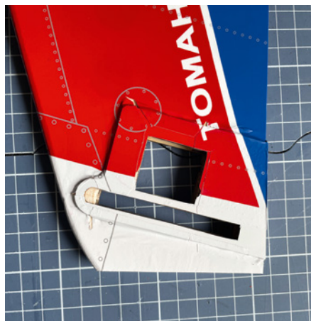
Im Leitwerk ist der Einbau von zwei Servos für die Höhenruder vorgesehen, was viel Gewicht im Heck bedeutet
