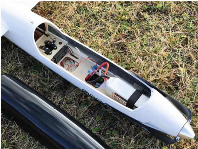
Der 6s-Antriebsakku sitzt direkt hinter dem Motor. Platz für größere Akkus ist ausreichend vorhanden. Unter dem LiPo liegt der Regler
