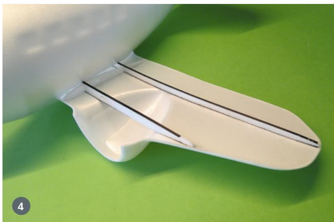
1) Die Bauteile aus 3-mm-Depron-Plattenmaterial sind sauber gefräst, alles passt genau. 2) Die Carbonflachprofile zur Holmversteifung müssen gesondert gekauft werden. 3) Höhenruderservo, Empfänger und die beiden Drehzahlsteller finden auf der zentralen Plattform ihren Platz. Das Stützgerüst verbindet Rumpf und Tragflächen. 4) Die untere Schale der linken Tragfläche. Was hier noch fehlt, das ist die Verkastung des Querruders. 5) Entgegen der Anleitung habe ich die Höhenrunder nicht getrennt angelenkt, sondern die beiden Hälften mit einem Carbonflachprofil verbunden
