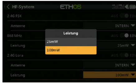
Im TW-Modus lässt sich die Leistung für die LoRA-Modulation vorgeben
