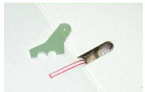
Für die sechs Überkreuzanlenkungen im Flügel liegen dem Bausatz passende GFK-Ruderhörner bei. Deren Position wird angezeichnet und dann ein Schlitz ausgefräst
