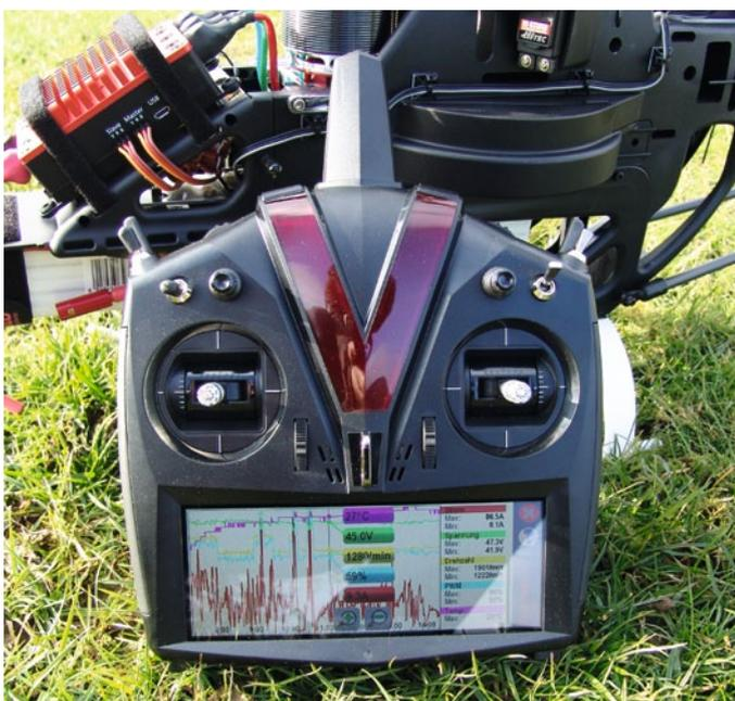
Die Analyse der Antriebsdaten ist sehr übersichtlich direkt nach Flugende auf dem Senderdisplay möglich. Die Daten werden automatisch gespeichert und sind auch später verfügbar
