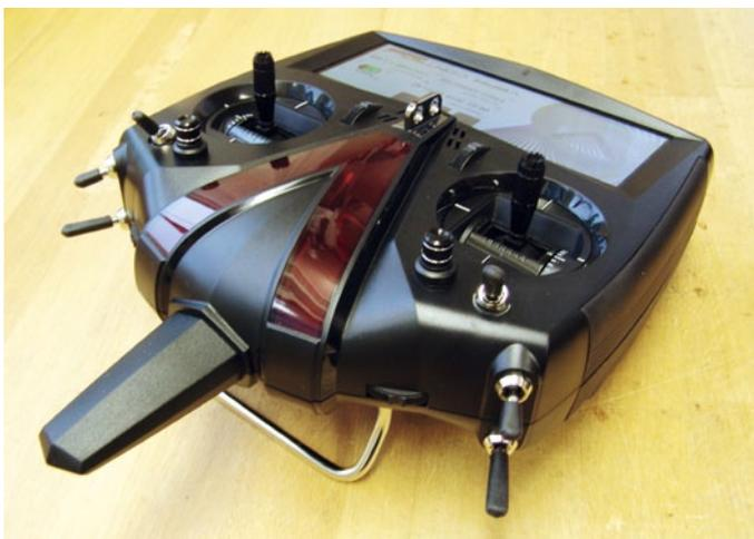
Der Sender ist komplett mit allen Schalt- und Drehgebern ausgerüstet. Die Trimmräder sind gummiert und bieten haptische und akustische Rückmeldung
