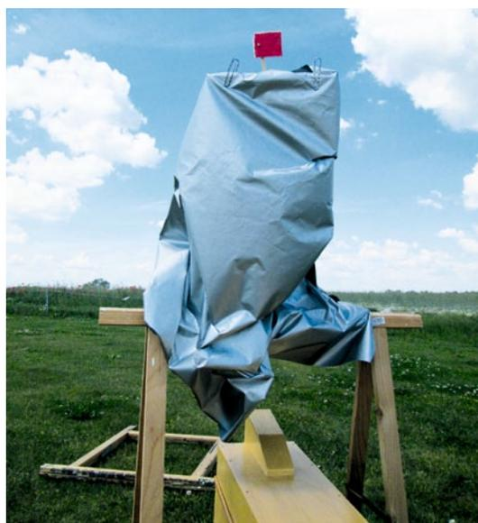
„Vogelscheuche mit Winkелеlement“. Hiermit wurde die Abschirmwirkung der mit Aluminiumpulver beschichteten Bespannung getestet
