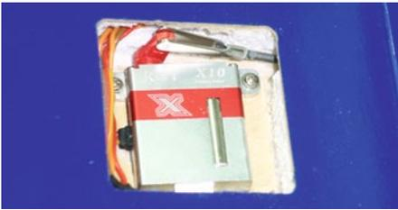
Die kräftigen KST X10 Servos werden von Tangent empfohlen und kommen auf allen sechs Ruderklappen zum Einsatz. Angelenkt wird standesgemäß überkreuz mittels M2,5-Gabelköpfen und Gewindestangen
