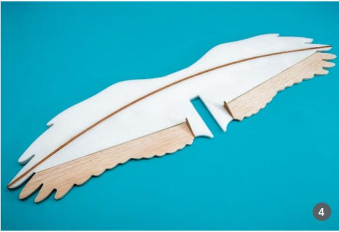
Der Flügel besitzt einen geschwungenen Holm in Form einer 3 x 6-mm-Kiefernleiste, welcher zwischen zwei Depron-Flügelteile geleimt wird. Als Querruder-Endleiste verwenden wir 6-mm-Balsa, welches wie beim Leitwerk unverschliffen bleibt. Ja wirklich, das fliegt! Zum Anschlagen verwende ich gern Vliesscharniere und Weißleim. Innen an den Balsaleisten sehen wir die beiden Ruderhörner, welche hier fürs Foto nach oben weisen, weil der Flügel auf dem Rücken liegt. In Wahrheit zeigen sie nach unten
