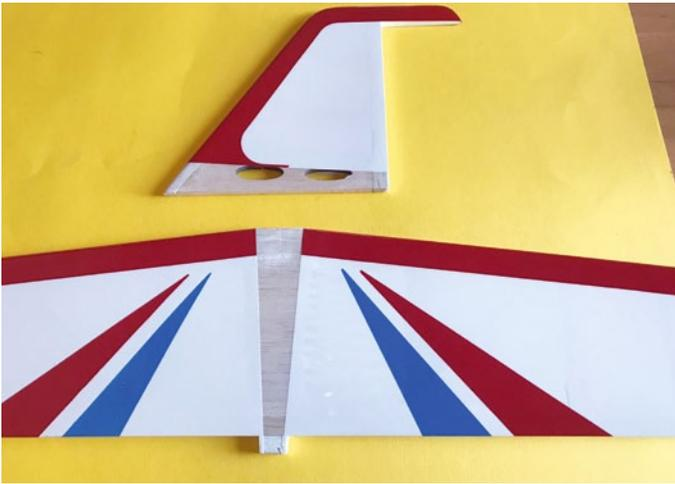
**Vor dem Verkleben des Höhen- und Seitenleitwerks mit dem Rumpf muss die Bügelfolie entfernt werden. Am besten geht dies mit einem biegsamen Stahl-Lineal und einem LötKolben**
