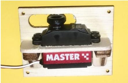
Beim Einbau der Querruderservos fällt auf, dass die vorgesehene Aussparung etwas zu breit ist, sodass man einen Zusatzspant aussägen und einkleben muss
