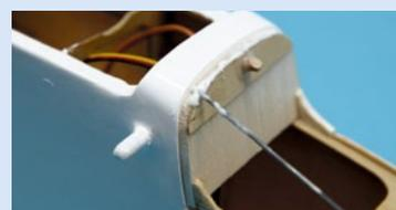
**Eingedickter Uhu plus endfest 300 wird spärlich am Haubenrahmen aufgetragen. Die relevanten Rumpfstellen wurden vorher mehrfach großzügig mit Trennwachs behandelt**
