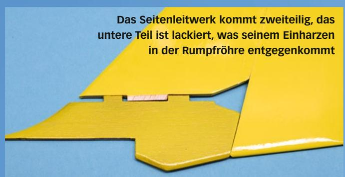
Das Seitenleitwerk kommt zweiteilig, das untere Teil ist lackiert, was seinem Einharzen in der Rumpfröhre entgegenkommt
