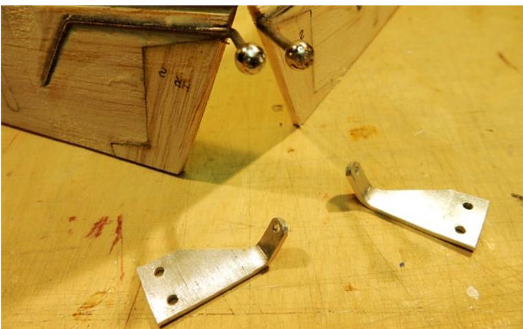
Die fertig gebogene und mit einer Kugel zu verlötende Ruderanlenkung musste durch Ruderhörner aus Alu-Blech ersetzt werden
