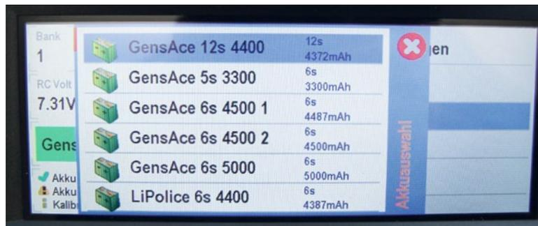
Ohne RFID-Leser, der den Flugakku beim Einschieben automatisch erkennt, kann dieser aus einer Liste angelegter Packs manuell ausgewählt werden
