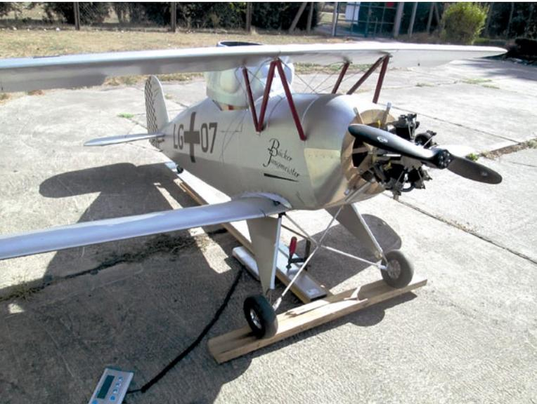
**Die Stunde der Wahrheit, die Bü-133 auf der Waage. Diese zeigt maximal 24,3 kg an und damit liegt das Modell unter der Zulassungsgrenze**
