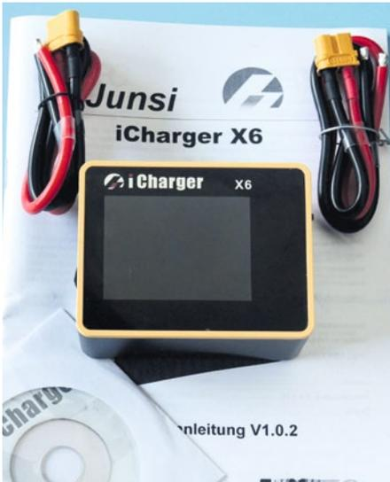
Der X6-Lader wird mit zwei Kabeln mit XT60-Stecker und deutscher Bedienungsanleitung geliefert
