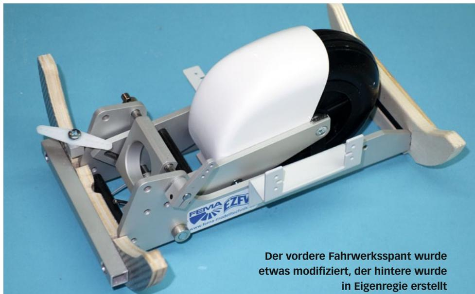
Der vordere Fahrwerksspannt wurde etwas modifiziert, der hintere wurde in Eigenregie erstellt
