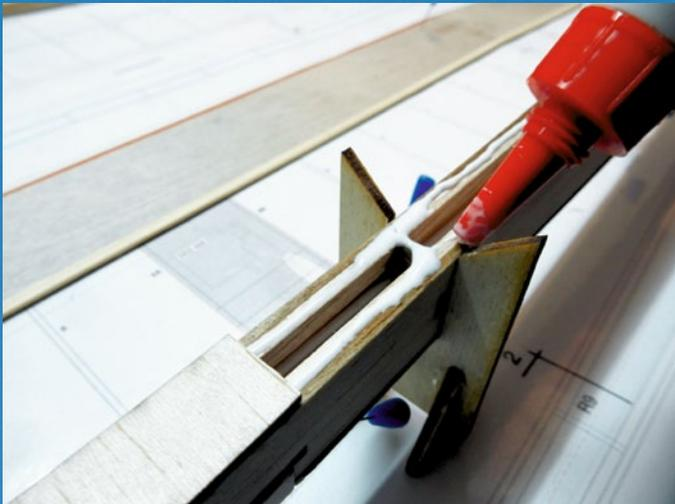
Eine Vorrichtung hält den Rumpf beim Einkleben des Leitswerksträgers gerade
