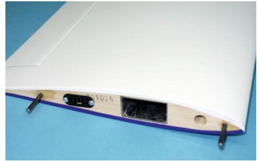
In die Wurzelrippen sind die Torsionsbolzen einzukleben und der Zentralstecker für die Servos zu installieren
