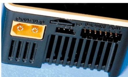
Die linke Seite mit den Anschlüssen für Akku, Servo, Balancer und dem Slot für eine Micro-SD Karte
