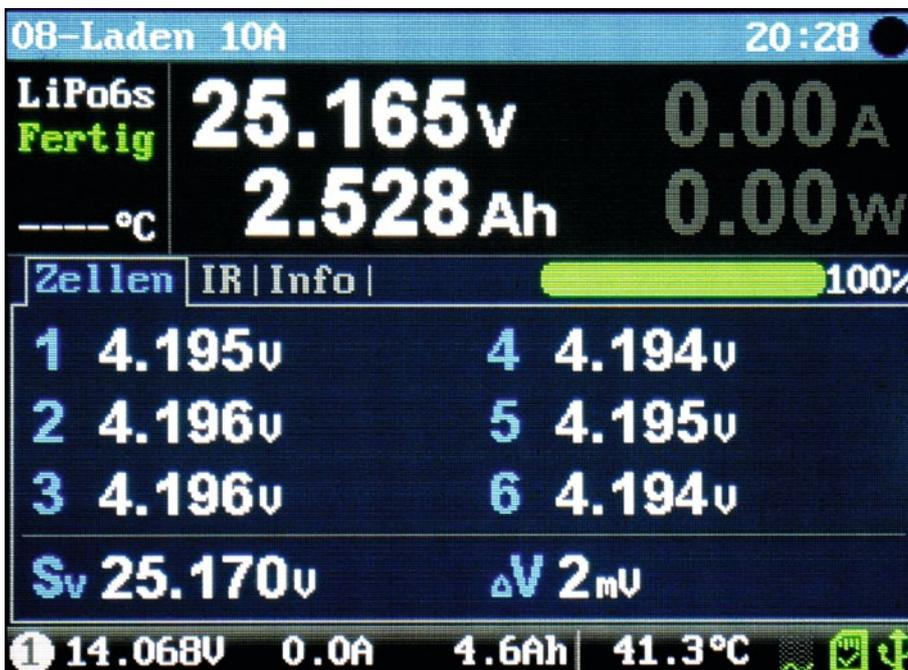
Display-Anzeige kurz nach dem Lade-Ende: Eine Zellenspannungsdifferenz von 2 mV ist hervorragend
