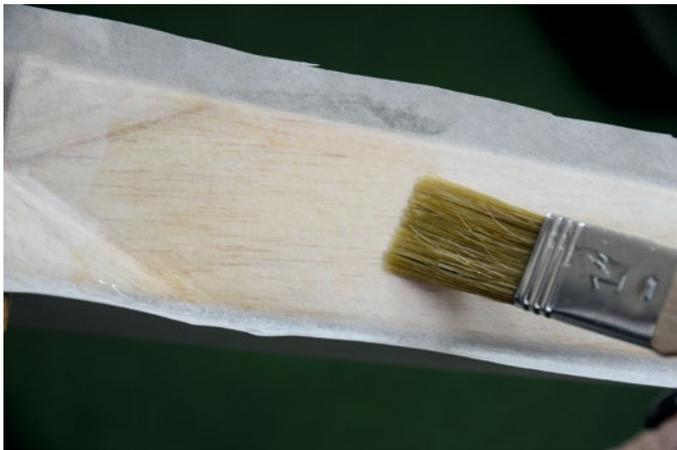
Das Bespannpapier ist auf dem Rumpf trocken aufgelegt und wird mit Kleister getränkt
