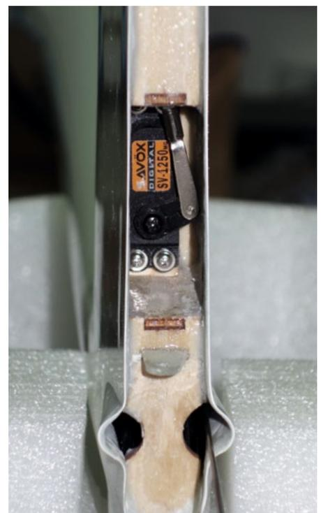
Blick auf das Höhenruderservo bei eingeklebtem Abschlusspanz
