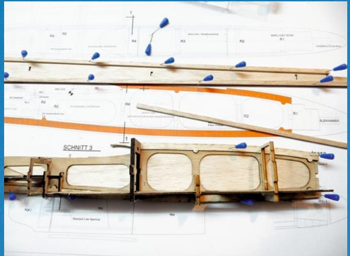
Die Rumpfsseitenwände sind von innen mittels Sperrholz verstärkt, bevor das Spantengerüst eingesetzt wird. Ein Plan im Maßstab 1:1 und sogar die Abdeckfolie liegt dem Bausatz bei
