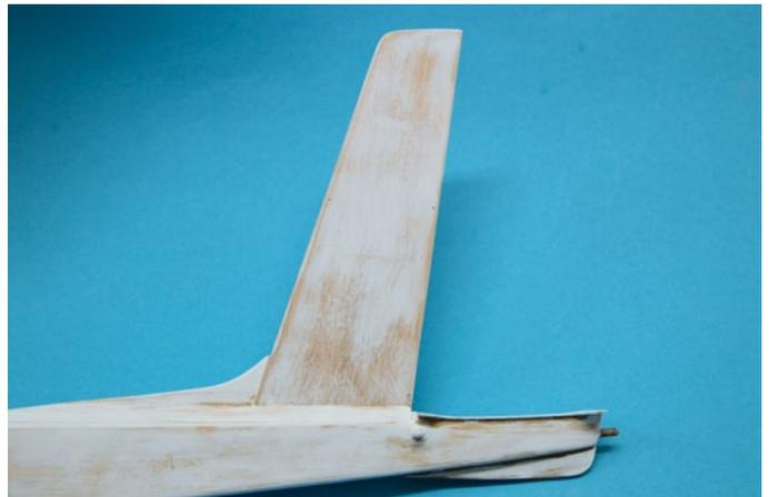
Das Spannfix Immun ist fast vollständig wieder herunter, der Rumpf aalglatt geschliffen, letzter Schliff mit 400er
