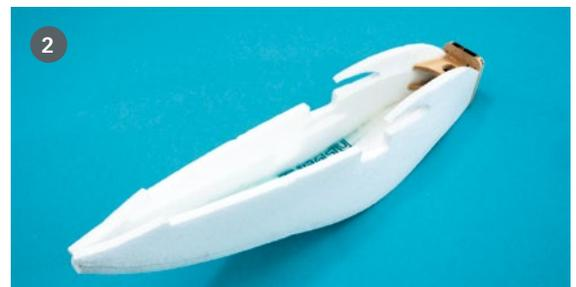
Indem die Einzelteile schon ihre Wölbung besitzen, ist es nicht schwierig, sie mit wasserfestem Weißbleim oder Uhu Por verzugsfrei zusammenzufügen. Der Motorsturz nach unten wird durch die Kontur der Rumpfsseitenwände eindeutig vorgegeben, und ein Motor-Seitenzug ist nicht notwendig
