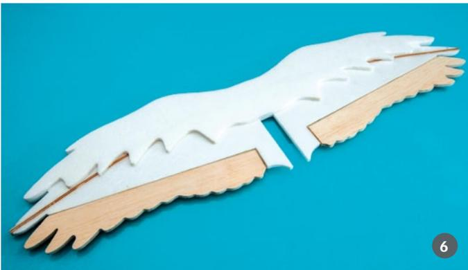
Wie gesagt: Ruderhörner nach unten, und jetzt kommt oben der Flügelaufdoppler drauf. Dadurch entsteht ein kreativ geformtes Kfm2-Profil, dessen Abstufung nach hinten unbedingt bestehen bleiben muss. Hier wird kurz gesagt ein Wirbel erzeugt, der dem Profil seine gutmütigen Flugeigenschaften verleiht
