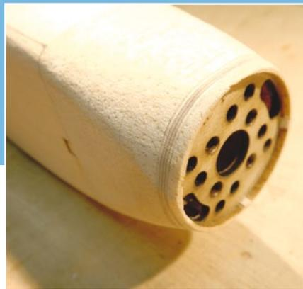
Anschließend lässt sich das Ganze am Rumpf befestigen und verschleifen
