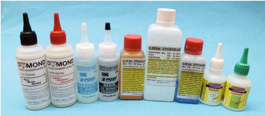
Klebesystem-Armada! Von links: Fünf-Minuten-Epoxy, 15-Minuten-Epoxy, schneller Härter (Tropfzeit zehn Minuten) für Epoxidharz L 285, Harz L 285, langsamer Härter für L 285 und ganz rechts 30-Minuten-Epoxy
