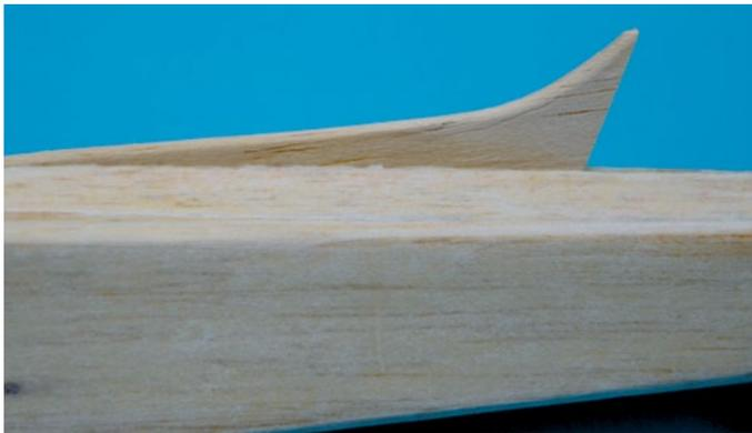
Der Rumpf ist zwei Mal grundiert und geschliffen, in diesem Stadium wird die ebenfalls grundierte und geschliffene Finne eingeklebt, bespannt und zwei Mal grundiert sowie geschliffen. Der gemeinsame dritte Anstrich überdeckt dann alles
