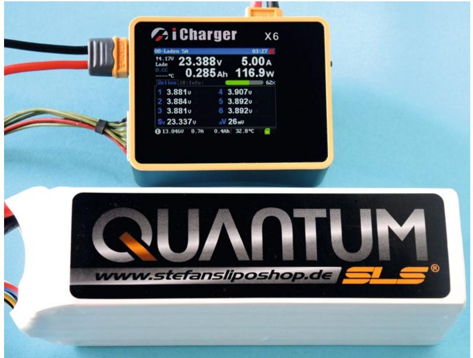
X6-Lader beim Laden eines 6s-LiPos mit 5.000 mAh Kapazität vom Typ Quantum
