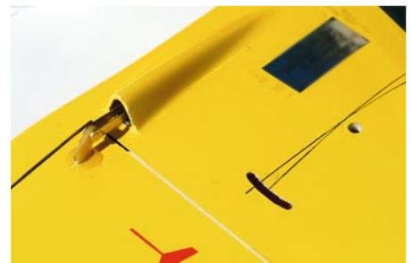
**Zu sehen sind die Seitenruderanlenkung mit CFK-Schubstange und Gabelkopf sowie Markierungen zur Kontrolle des Pendelhöhenruders in Normalfluglage und Tiefenzumischung für Butterfly**
