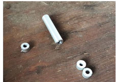
**Da im privaten Fundus gerade keine längeren Schrauben zur Verfügung standen, wurden die Abstandshülsen um 10 mm gekürzt und die abgesägten Abschnitte zwischen Motor und Zwischenspant gelegt**
