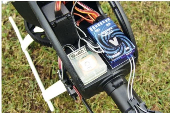
Das kompakte VStabi Neo VLink mit frontseitigen Steckplätzen ist die aktuelle Empfängergeneration bei Mikado und bietet ab Werk eine integrierte 3-Achs-Sensorik. Links am Gehäuse befinden sich die Sensor-Eingänge
