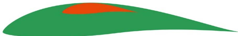
Abbildung 12: Vergleicht man zwei identische Profile unterschiedlicher Tiefe, erkennt man, dass sich die Kontur des kleineren Profils stärker krümmt
