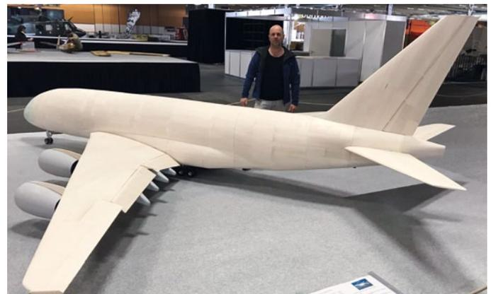
Hier ist der riesige A380-800 von Christopher Ferkl noch im Rohbau. Der Airliner hat eine Spannweite von 5.730 mm und eine Länge von 6.130 mm
