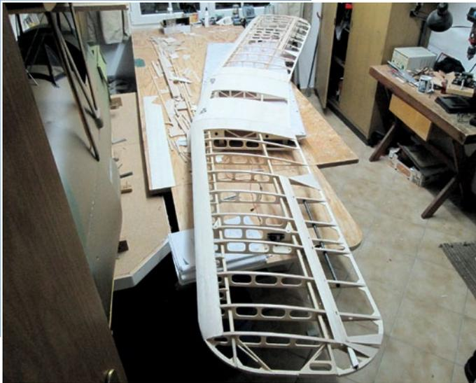
Die untere Fläche ist fertig zum Bespannen. Gut zu sehen ist das eingebaute Servo, das später über Schubstangen auch die obere Querruderfläche mit ansteuert
