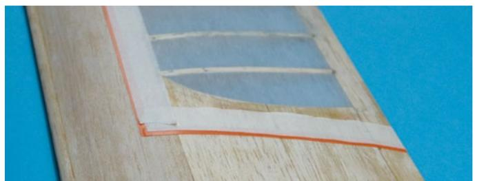
Der freiliegende Teil der Flächen bekommt ebenfalls Zierfarbe, abgedeckt wurde mit speziellem Band aus dem Lackiererbedarf. Keinesfalls Tesa oder Ähnliches verwenden
