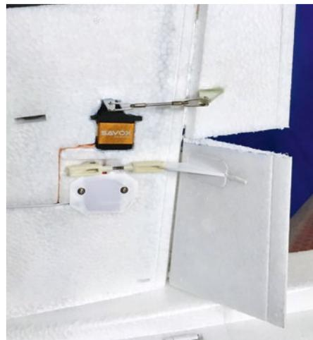
**Klappen gefahren, Stufe 2, das ist die Stellung für die Landung**
