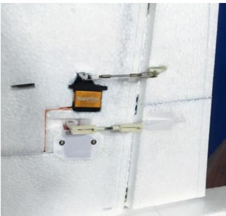
**Einbau fertig, Ruder angelenkt, man sieht die Kabelverlegung bis zum bereits vorhandenen Kanal des ursprünglichen Querruderservos**
