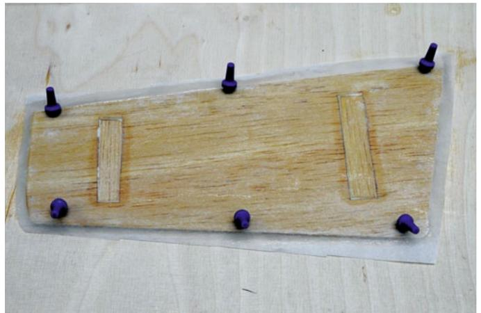
Bei den Vollbalsateilen der Leitwerke wird ebenfalls gekleistert und aufgespannt
