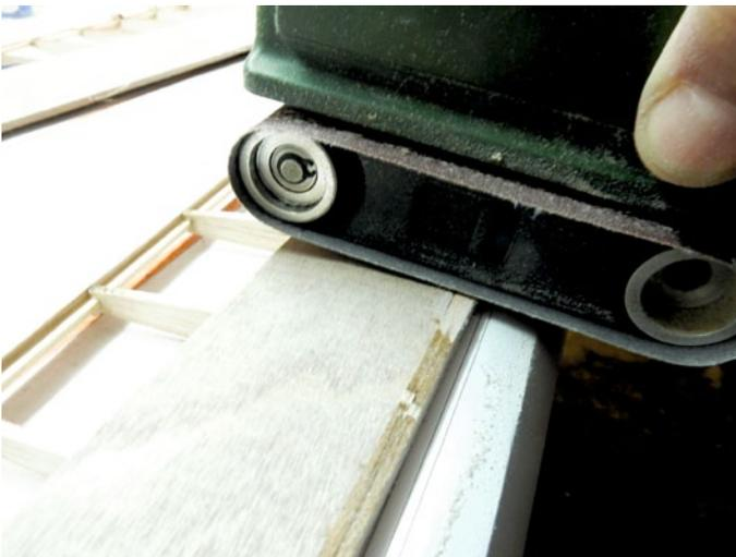
Ist anschließend die Nasenleiste angeklebt, muss zum Schluss alles verschliffen werden
