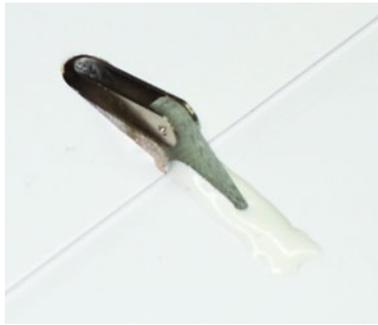
Wird das Ruderhorn mit eingefärbtem Langzeitharz eingeklebt, sieht es später so aus
