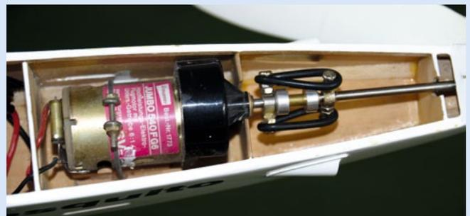
Alles nur nostalgische Show. Die O-Ringe sind außer Betrieb, die Wellenteile über das Messingrohr und Stellringe starr miteinander verbunden
