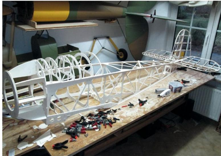
Aufgrund des Stecksystems geht auch der Rumpfaufbau ohne eine Helling. Einige Spannten müssen zuvor gedoppelt werden
