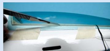
**Die grob mit der Schere zugeschnittene Kabinenhaube wird fixiert und am Rumpfrand entlang mit dem Skalpell angeritzt. Der labile Haubenrahmen ist mit einem Faden an seine Rumpfaufgabe herangezogen**
