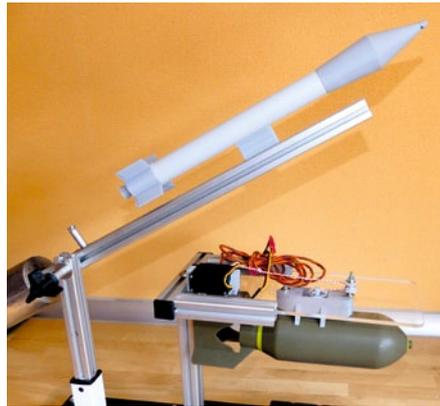
Die Bomben- und die Raketenattrappen sind für die 1:4-Corsair eines Klubkameraden angefertigt worden. Die Bombe hat eine über Servo und Seilzug zu betätigende Abwurfvorrichtung
