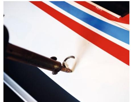
**Auch der Rumpf ist noch verschlossen und die Folie muss noch entfernt werden. Auch hier hilft ein LötKolben**
