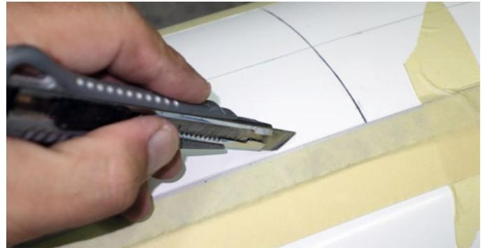
Die Fahrwerksklappen werden mit der Rückseite eines Cuttermesser ausgetrennt. So ergeben sich gerade und schmale Schnittkanten. Die Ausschnitte werden angezeichnet und ein Stahllineal gibt die Führung für das Messer
