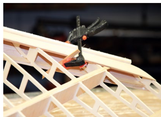
Um die Beplankungsplatte der Nasenrundung entsprechend zu befestigen, helfen Zwingen und Arretierleisten
