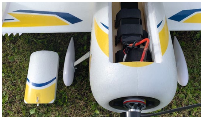
Zum Platzieren des Flugakkus verfügt der Rumpf zwischen Motor und Kabine über eine große abnehmbare Klappe
