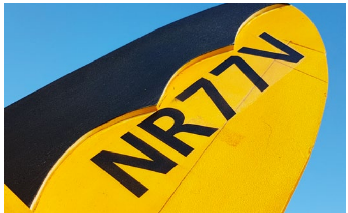
Die Aufkleber entstanden mit einem normalen Tintenstrahldrucker auf Klebefolie. Klarlack versiegelt das Ganze
