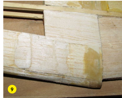
Eine zweite Beplankung ist analog zum Keil verschäftet und geschliffen worden
