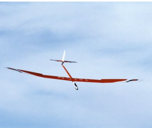
Steile Abstiege sind dank Butterfly und großer Wölbklappenausschläge kein Problem. So lässt es sich auch auf kleineren Plätzen sicher landen
