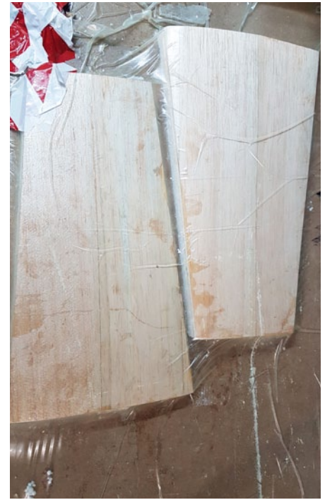
Bepanken von Styro-Flächen mit PU-Kleber im Vakuum-Verfahren – das geht auch mit einfachen Bordmitteln
