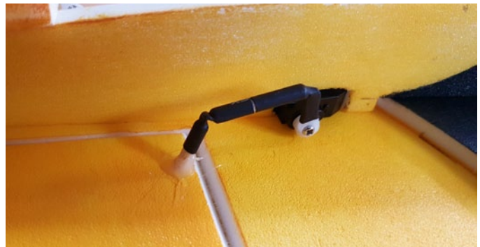
Das Höhenruderservo sitzt kopfüber im Rumpfheck, die Querruderservos in den Rumpfsseitenwänden
