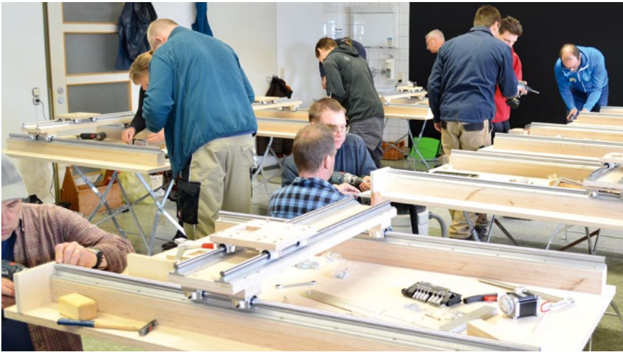
Bei den Workshops bauen die Kurs-Teilnehmer ihre eigene CNC-Fräse, mit der sie dann Zuhause arbeiten. Da kann dann, ganz nach den individuellen Bedürfnissen und Vorstellungen, gefräst werden
