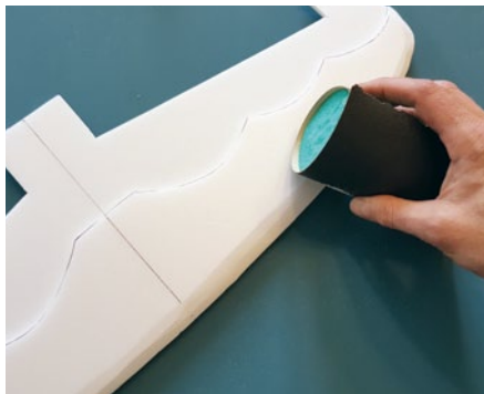
Danach die Nasenleiste dem Plan entsprechend vorsichtig schleifen
