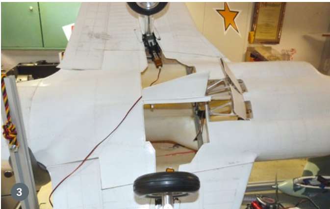
Fräsarbeiten am Fahrwerksbein ließen sich in der heimischen Werkstatt umsetzen (1). Die Umsetzung der Lenkmechanik am ein- und ausschwenkenden Bugfahrwerk lässt sich hier gut erkennen (2). Nach teils mühevoller Umarbeitung der Klappen sitzt das Hauptfahrwerk zum ersten Mal montiert im Rumpf (3). Alle drei Fahrwerksbeine inklusive der elektrischen Bremsen sind einbaufertig (4)
