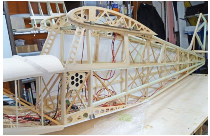
Der Rumpf ist im vorderen Bereich mit 1,5er-Balsa beplankt. 20 x 20-mm-Stryroträger, mit 1,5er-Balsa beplankt, bilden als Längsträger das Rückgrat der Rumpfkonstruktion
