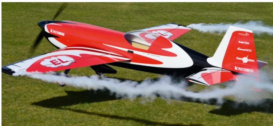
Eine elektrisch arbeitende Rauchanlage in den Flügelspitzen eines Großmodells testen zu können, dafür ist die Extra 330sc ideal geeignet
