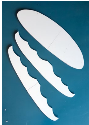
Hier sieht man die Tragflächenteile. Ein Holm wird nicht benötigt
