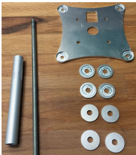
Die Alu-Rohre sollen nicht im GFK des Rumpfs reiben und diesen zerstören, darum entstanden Auflagen mit Zentrierlöchern auf der Drehmaschine
