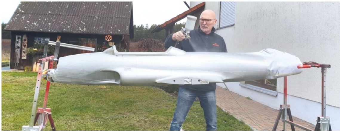
Der erste T-Bird wird in Silber mit RAL 9006-Basislack lackiert
