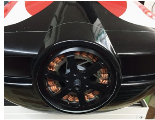
Nachdem alles seinen Platz gefunden hat, schaut die Motorfront an gewünschter Stelle zentriert und mit korrektem Sturz sowie Zug aus der Haube
