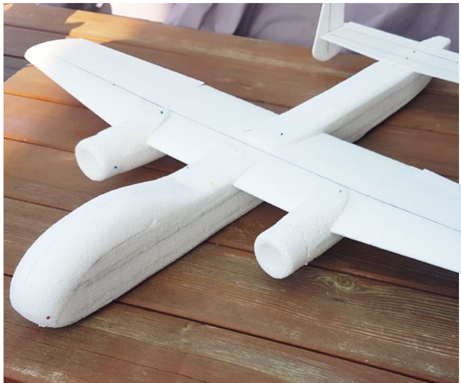
Aus EPP-Resten entstand spontan der Bau einer Ju-288 – die Schnittdaten stehen als Download auf www.flugmodell-magazin.de zur Verfügung
