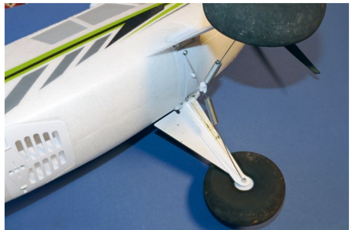
Die klassisch anmutende Federdämpfung kompensiert auch härtere Landungen sehr gut
