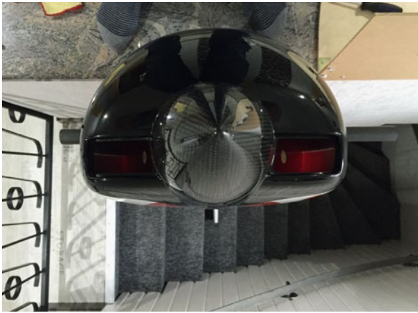
Der Rumpf ist der Länge nach an der Wand der Kellertreppe befestigt, um die Platzierung des Motors mit aufgesetzter Motorhaube auf einer gut erreichbaren Montagehöhe vorsichtig zu ermitteln. Der aufgesetzte Spinner dient zur exakten Positionierung
