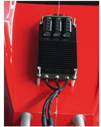
Der Regler ist aufgebockt auf Abstandshaltern, sodass er von allen Seiten gut gekühlt werden kann
