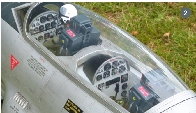
Unter 25 kg Abfluggewicht bei 2.680 mm Spannweite und ansprechendem Scale-Ausbau – die T-33 von Skymaster ist ein Hingucker (1). Blick ins Scale-Cockpit. Die Nassschiebilder und das Kreide-Weathering sind mit Klarlack sicher versiegelt (2). Zum Starten und Landen eignet sich eine Hartbahn optimal. Die Federwirkung ist gut (3)
