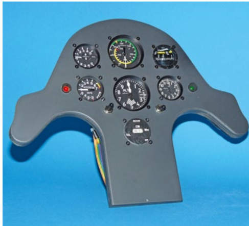
Die Instrumente im Cockpit sind funktionsfähig, was bei einem Maßstab von 1:2 sehr gut zur Geltung kommt. Wie man das macht, ist in einem Modell AVIATOR-Workshop ausführlich beschrieben worden
