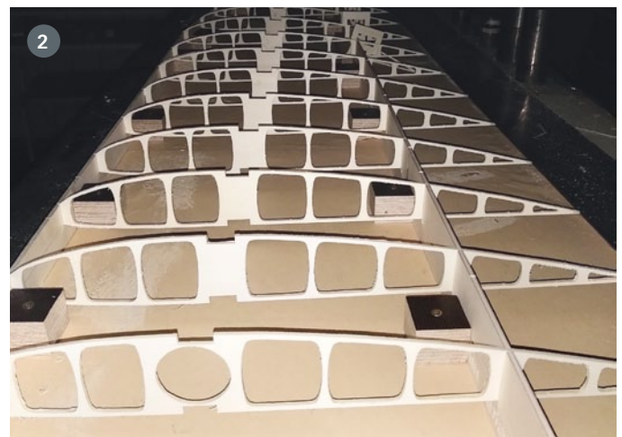
Mithilfe der CNC14-Fräse können die einzelnen Spanten dann Präzise ausgeschnitten werden (1). Das Ergebnis: Exakte und passgenaue Holzteile für die C10 (2)
