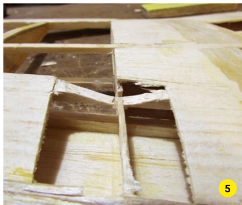
Der Keil im Holm ist herausgeschnitten
