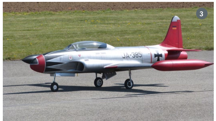
Unter 25 kg Abfluggewicht bei 2.680 mm Spannweite und ansprechendem Scale-Ausbau – die T-33 von Skymaster ist ein Hingucker (1). Blick ins Scale-Cockpit. Die Nassschiebilder und das Kreide-Weathering sind mit Klarlack sicher versiegelt (2). Zum Starten und Landen eignet sich eine Hartbahn optimal. Die Federwirkung ist gut (3)
