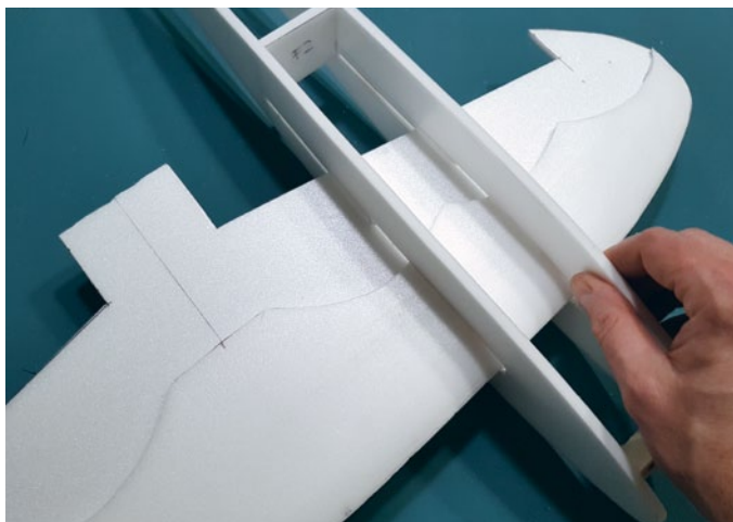
Der Flügel dient zuerst als Montagehilfe für den Rumpf – die Seitenwände werden aufgeschoben und genau ausgerichtet – und danach wird alles miteinander verklebt
