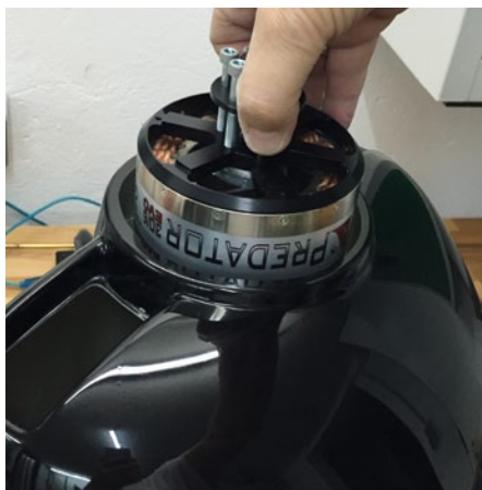
Der Motor Predator 30/6 Evo passt mit dem Durchmesser perfekt unter die Motorhaube
