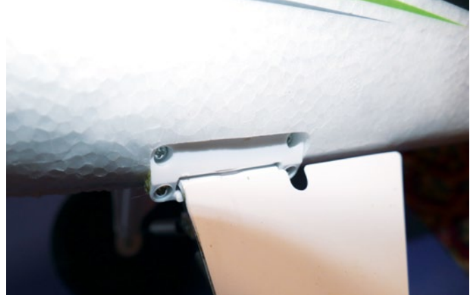
Clever gemacht ist die schwenkbar gelagerte Fahrwerksaufhängung in einem Plastiknlay
