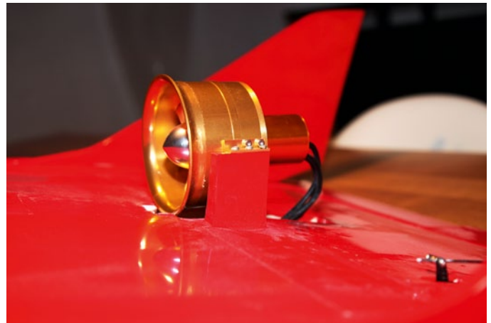
Der hinten sitzende, in Aluträgern befestigte 90-mm-Impeller erfordert Ausgleichsgewicht zum Erlangen des Schwerpunkts
