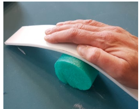
Rumpfboden und -deckel vor der Montage mit Hilfe einer Schwammwadel in Form gewalkt
