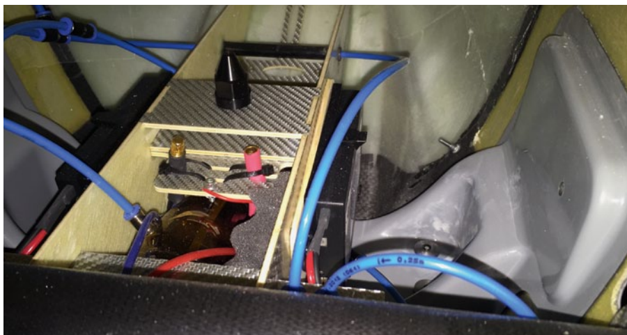
In die Akkuschiene und damit Schwerpunkt-optimal ist die Rauchanlage bestehend aus Elektronik, zwei Akkus, Tank und Pumpe integriert
