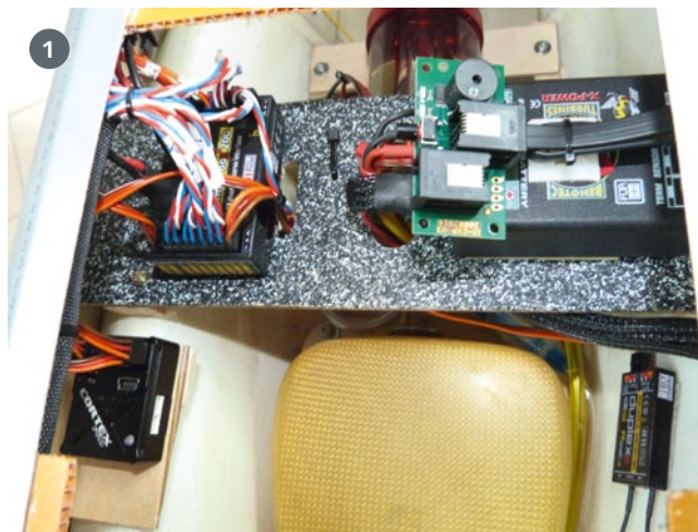
Die Jeti CB 200 kommt in Verbindung mit dem CortexPro-Kreisel zum Einsatz. Die Turbinen ECU ist auch auf dem RC-Brett platziert (1). Bis die T-33 so schön in der Sonne glänzen konnte, war einiges an Aufwand ins Projekt zu stecken (2)
