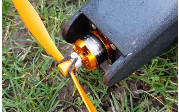
Ein Außenläufer Typ D-Power 2814 oder ein vergleichbarer Motor in Kombination mit einem 7 x 6-Zoll-Propeller sorgt für rasante Flugleistungen
