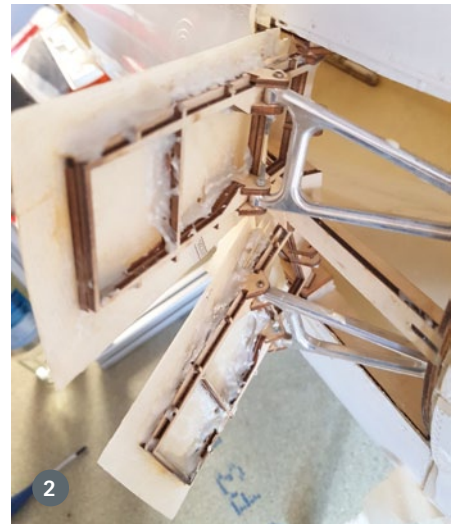
Eine der beiden bestellten T-33 von Skymaster in der frühen Bauphase – das Fahrwerk ist schon probeweise fertig (1). Die Speedbrakes am Rumpfboden im Auslieferungszustand: Die Holzteile sind leider sehr schlampig verleimt (2)
