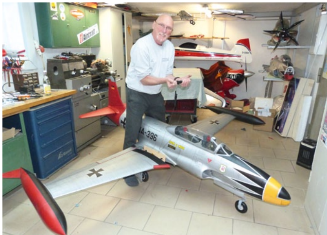
Die T-33 ist flugfertig und wird ausgewogen. Dazu wurden zwei Sperrholzrippen angefertigt und auf die Steckung geschoben
