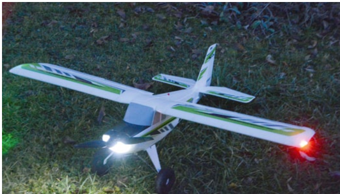
Beleuchtung und Randbogenschutz
