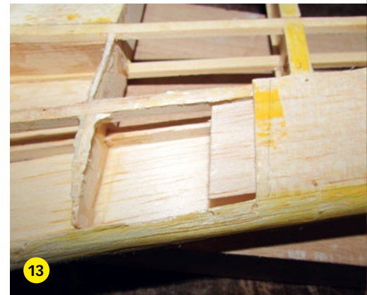
Eingeklebter Doppler mit gleichen Materialeigenschaften
