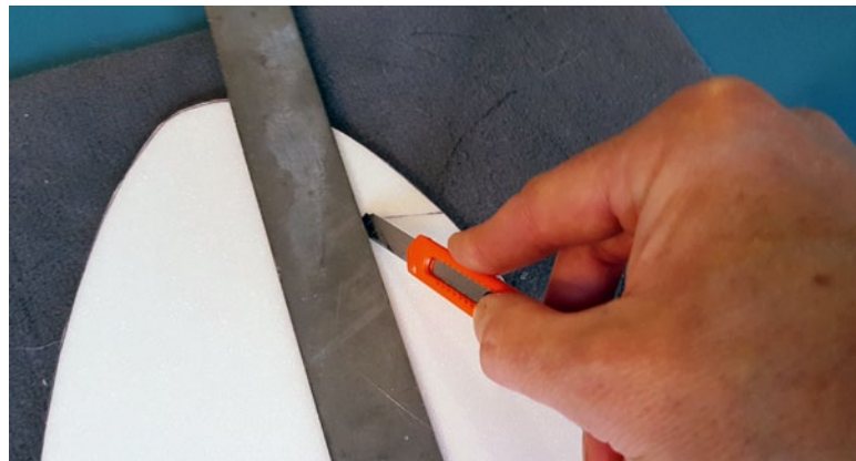
Schneidet man die Querruder leicht schräg ab, können sie ohne Schleifarbeit auf der gegenüberliegenden Seite montiert werden
