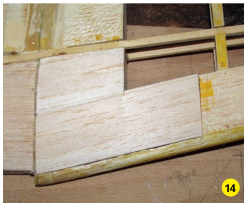
Ein neues Stück Beplankung verschließt den Flügel
