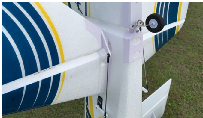
Die beiden Servos für Höhen- und Seitenruder sitzen hinten im Rumpf und steuern über Gestänge die Ruderklappen an
