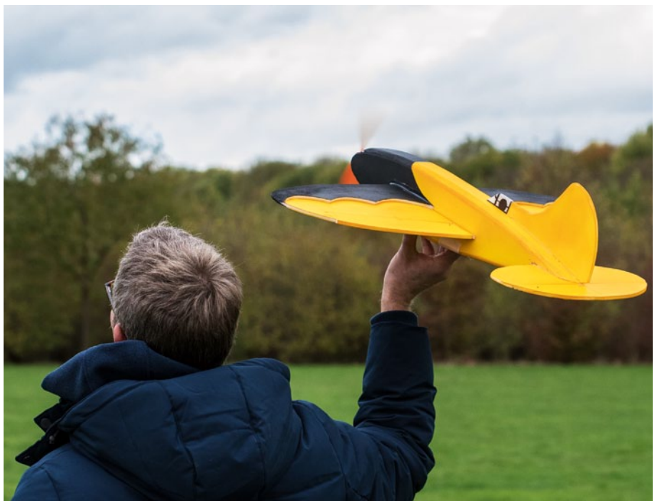
Die Jupiter Bee wird mit Halbgas leicht aufwärts in die Luft geschoben, so ist der Start absolut problemlos
