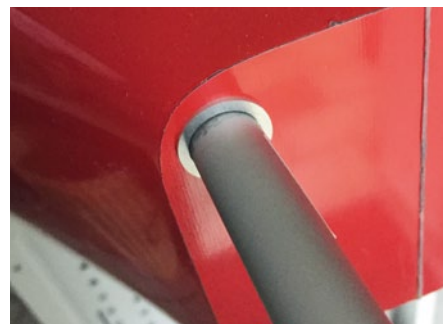
Die Alu-Rohre sollen nicht im GFK des Rumpfs reiben und diesen zerstören, darum entstanden Auflagen mit Zentrierlöchern auf der Drehmaschine
