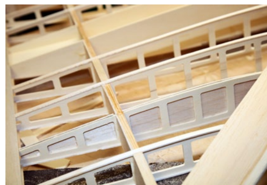
Beplankungsbretchen und Aufleimer sind aufgebracht. Bei der Impeller-Version geht es mit der Verstärkung für die Seitenleitwerksrippe weiter
