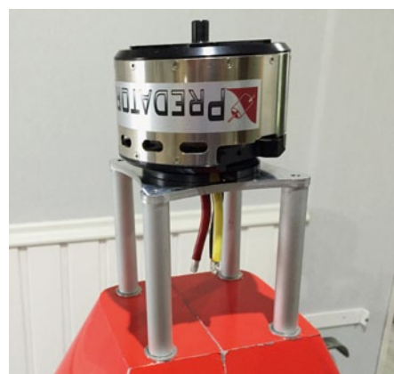
Zum Ermitteln der Position, an der der Motorträger auf dem Brandschott zu befestigen ist, nimmt er zur Probe Platz
