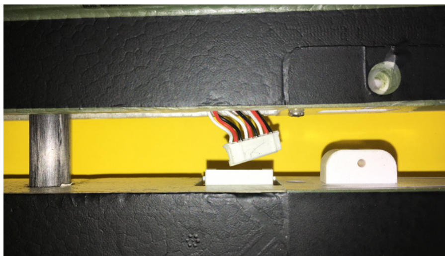
Für die Verbindung der Querruder, der Landeklappen, des Fahrwerks und der Beleuchtung gibt es einen Zentralstecker
