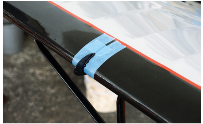
Die Aufnahmen für die Vorflügel wurden mit eingefärbtem Harz verklebt
