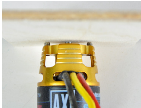
Fest andrücken, bis die Lage der Löcher ausreichend tief markiert sind
