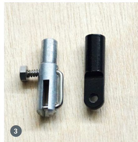
1) Das Spornrad ist blattgefедert. 2) Die Ballonreifen können mit Luft befüllt werden. Leider war diese Konstruktion ab Werk nicht dauerhaft dicht zu bekommen. 3) Die originalen Befestigungen der Tragflächenstreben (rechts) wurden gegen Exemplare mit Schnellverschlüssen getauscht
