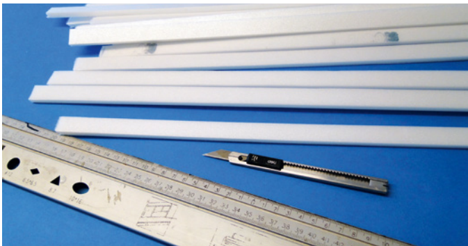
Am Anfang schneidet man die 15 mm breiten Stege und Holme aus 6 mm starkem Depron
