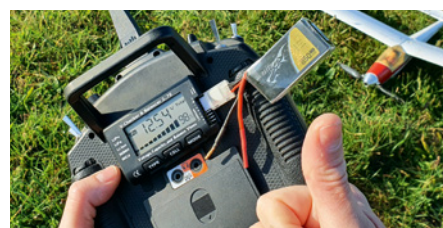
So befestigt kann der Akku-Tester nicht vergessen werden
