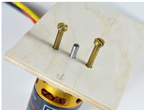
Das nächste Pärchen markieren, dazu Befestigungsschrauben eindrehen
