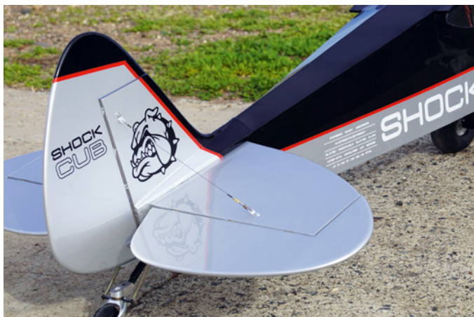
Stabilität bekommt das Leitwerk erst durch die Verspannung mit Stahlseilen
