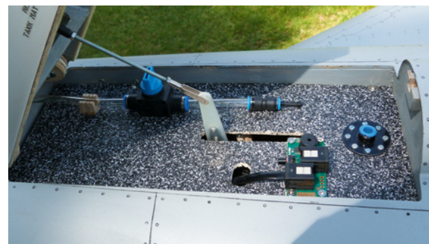
Unter der Speedbrake befinden sich die Betankungsanschlüsse für Kerosin und Smoke
