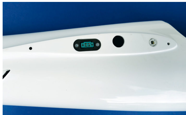
Der Flächenanschluss ist gut vorbereitet und die Fertigung des GFK-Rumpfs sehr gut
