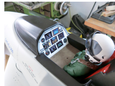
Das Cockpit mit Instrumenten aus selbst hergestellten Wasserschiebebildern
