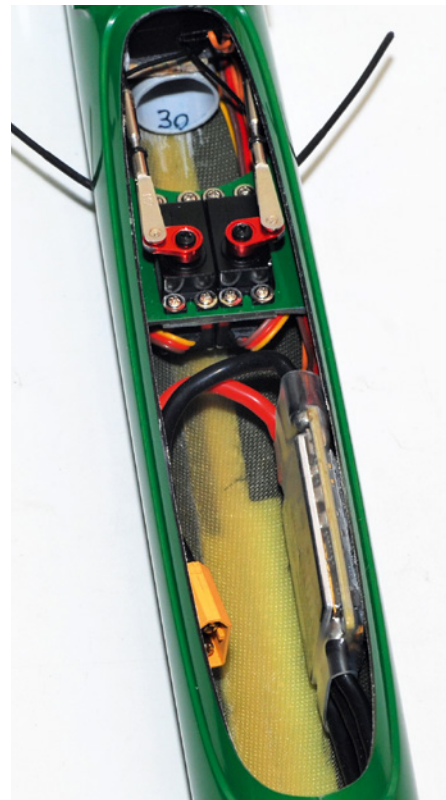
Unter die Haube passen maximal 3s-LiPos mit 2.200 mAh Kapazität. Rein präventiv habe ich ein 30er-Ballastrohr eingebaut
