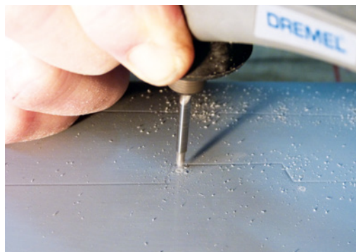
Die Nietens werden mit einem Dremel und einem angeschliffenen Gravierstichel eingebracht
