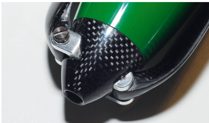
Der zur RFM-Luftschraube passende 30-mm-Turbospinner mit veretztem Mittelstück vom gleichen Hersteller sitzt wie angegossen
