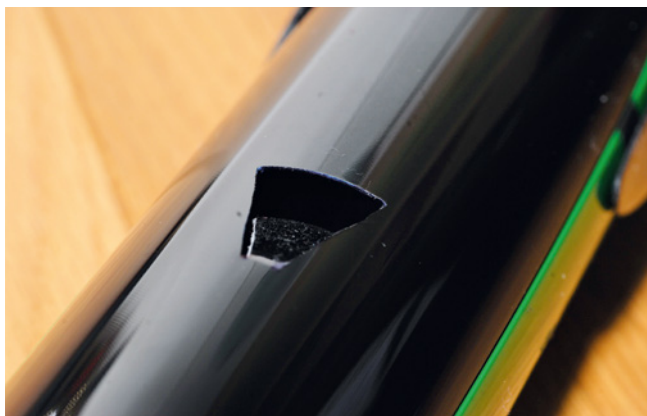
Durch eine unauffällige Hutze in der Kabinenhaube kann entstehende Wärme entweichen
