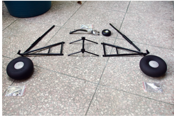
Das Hauptfahrwerk macht ordentlich was her, hat aber teilweise etwas zu viel Spiel
