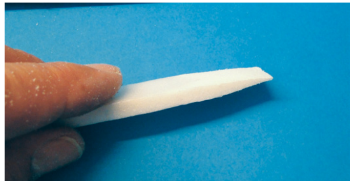
Die nach hinten ragenden Stege werden am Ende konisch zugeschliffen
