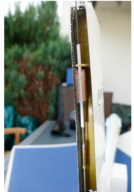
Die noch selbst einzubauende Höhenrudieranlenkung wird vom Seitenruder abgedeckt
