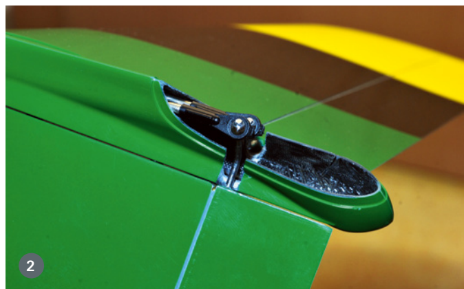
1) Das komplette Zubehör für die Leitwerksanlenkung liegt bei, während die Bowdenzugaußenhüllen bereits im Rumpf verklebt sind. 2) Aufgrund der raffinierten Konstruktion bleibt das Heck trotz der Öffnungen für die Anlenkungsgestänge stabil genug
