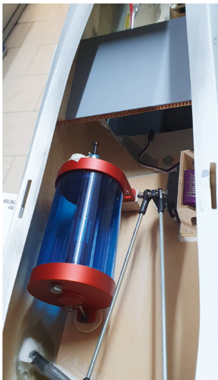
Der eingebaute Hoppertank
