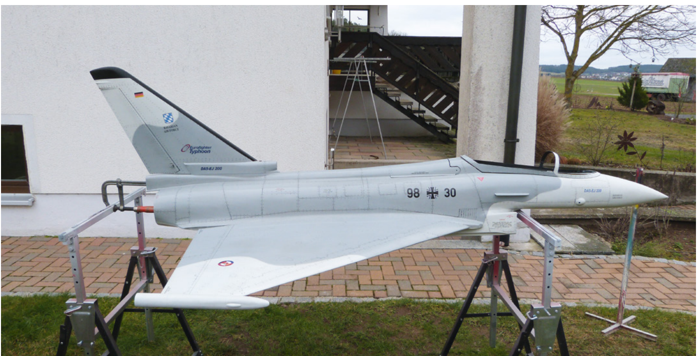
Als letzter Arbeitsschritt wird der Eurosport komplett mit Zweikomponenten-Klarlack versiegelt
