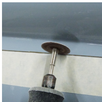
Die Speedbrake am Rumpfrücken wird ausgeschnitten
