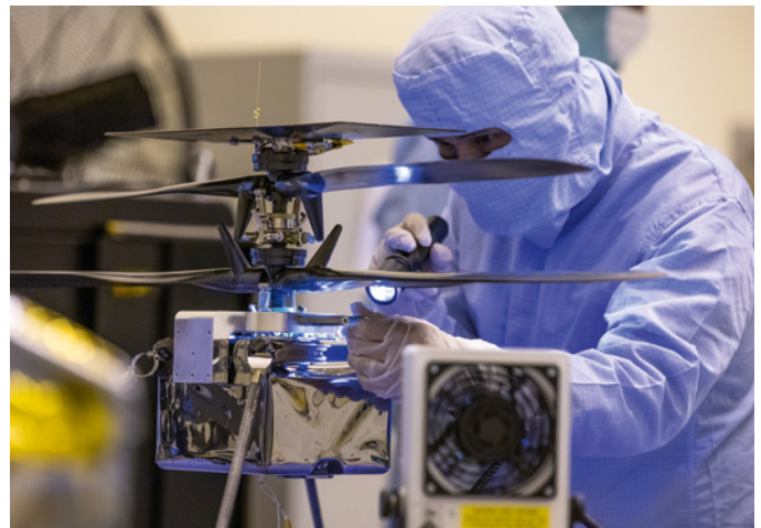
Finale Prüfung des Antriebssystems, bevor die Drohne für die Reise zum Mars vorbereitet wurde
