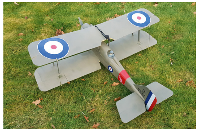
Die Folie wurde nach dem Bespannen lackiert und mit Decals – die leider durchscheinend sind – versehen
