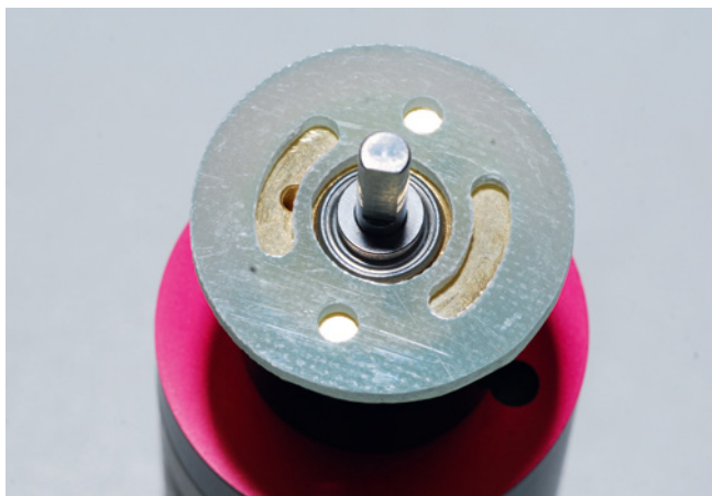
So ist der mitgelieferte Motorspant ungeeignet: Keine Befestigungslöcher vorhanden und Öffnungen für die Kühlluft deplatziert
