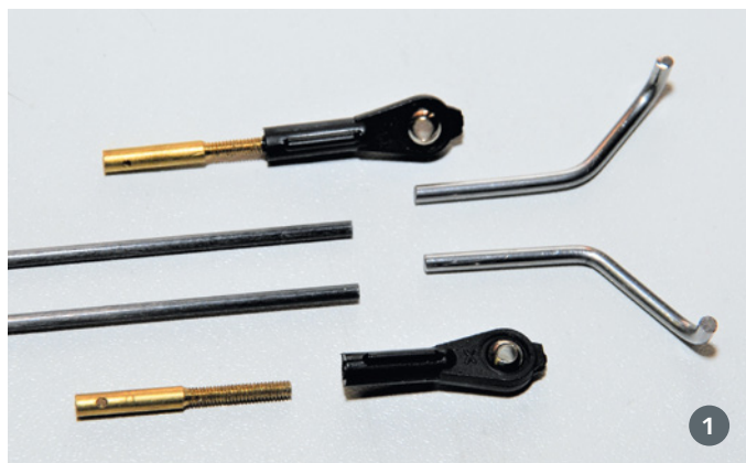
1) Das komplette Zubehör für die Leitwerksanlenkung liegt bei, während die Bowdenzugaußenhüllen bereits im Rumpf verklebt sind. 2) Aufgrund der raffinierten Konstruktion bleibt das Heck trotz der Öffnungen für die Anlenkungsgestänge stabil genug
