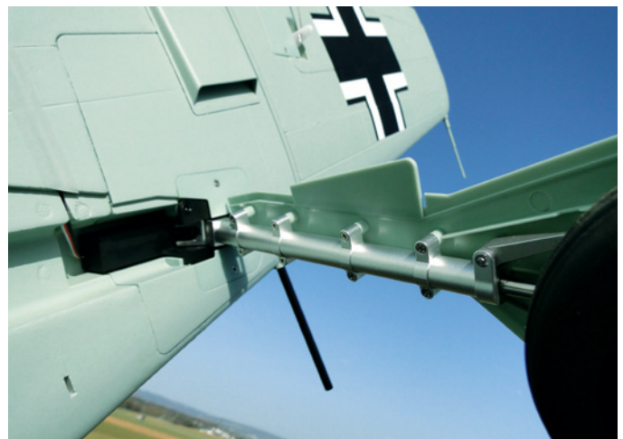
Das robuste und absolut rasentaugliche Einziehfahrwerk ist gefedert
