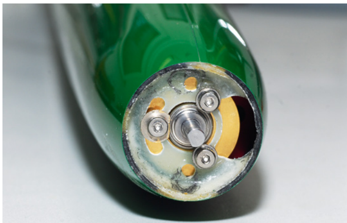
Sieht nicht danach aus, doch der modifizierte Spant hält definitiv bombenfest. So hat auch Kühlluft in Verbindung mit einem Turbospinner eine Chance
