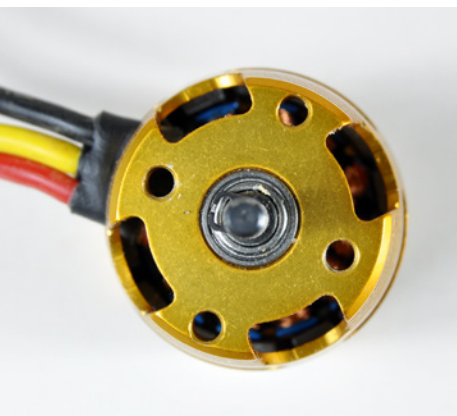
Vier Befestigungs-Schraublöcher, aber paarweise Anordnung
