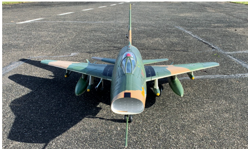
Der Luftenlass der F-100D zeichnet dieses Muster aus – ein typisches Merkmal von Jets aus den 1950er-Jahren
