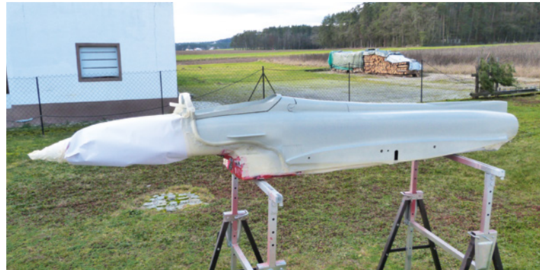
Der Eurosport wird lackiert. Durch das 13-Millimeter-Schaumstoffrundmaterial werden die Übergänge fließend
