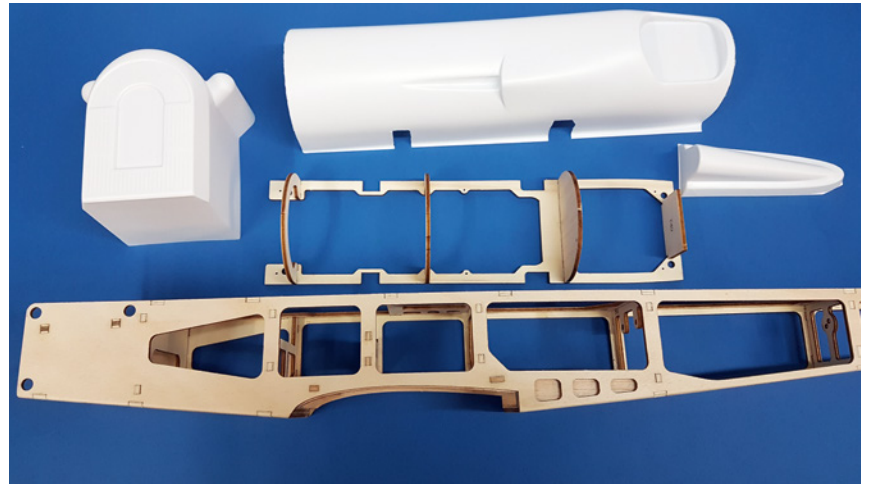
Die Motorhaube vorne und der mittlere Kabinenbereich sind aus ABS. Letzteres ist später komplett demontierbar für die Akku-Montage
