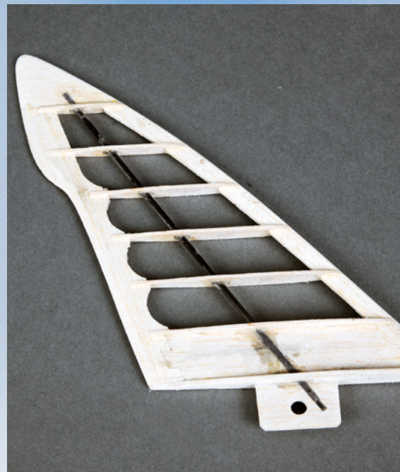
Die Heckflosse in Rippenbauweise. Auch hier stabilisiert ein CFK-Holm
