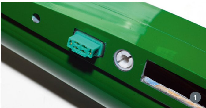
1) Wenn die MPX-Buchse so angebracht wird, müssen die zum Empfänger führenden Kabel im Inneren des Rumpfes nicht so extrem abgeknickt werden. Das Multilock-System wurde in Eigenregie nachgerüstet. 2) In der Fläche kommen bewährte KST X10 in Servorahmen zum Einsatz. Die Servoschächte werden später bündig zur Profilkontur mit farblich passenden GFK-Deckeln verschlossen
