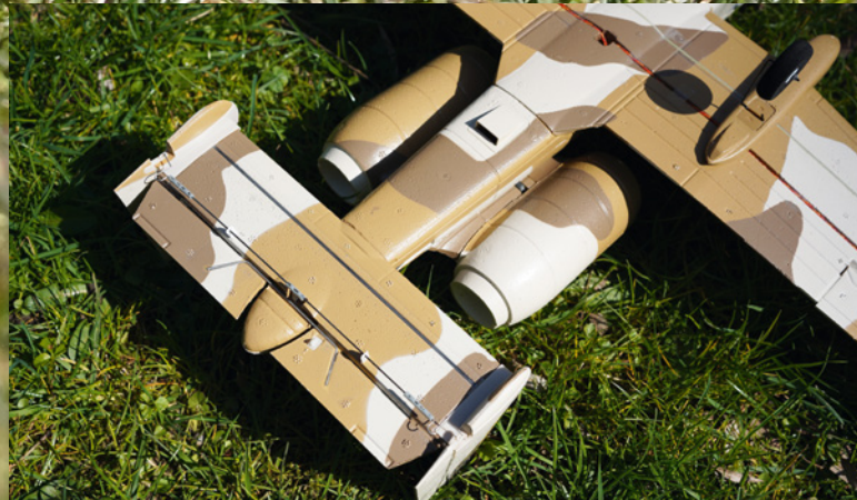
Präzise, spielfreie und seit der Ur-Version bewährte Anlenkungen – alles fertig installiert
