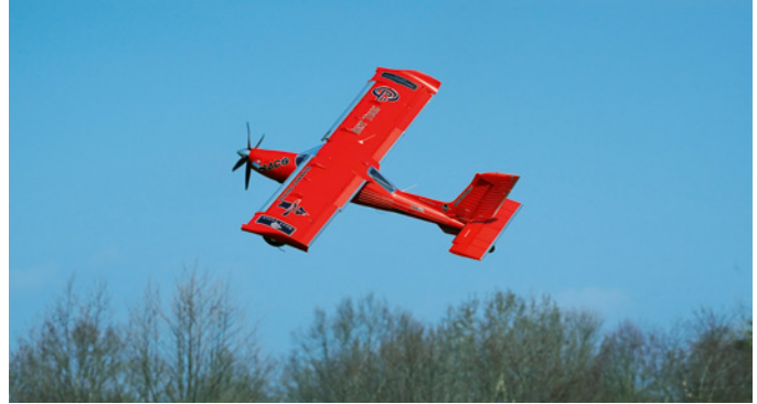
Im Slip über dem Platz, das gelingt dank gesetzter Klappen, der Vorflügel und sehr guter Langsamflugeigenschaften
