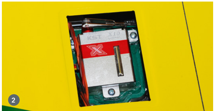
1) Wenn die MPX-Buchse so angebracht wird, müssen die zum Empfänger führenden Kabel im Inneren des Rumpfes nicht so extrem abgeknickt werden. Das Multilock-System wurde in Eigenregie nachgerüstet. 2) In der Fläche kommen bewährte KST X10 in Servorahmen zum Einsatz. Die Servoschächte werden später bündig zur Profilkontur mit farblich passenden GFK-Deckeln verschlossen
