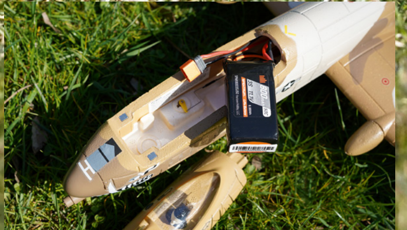
In der Version 2 lassen sich 3s-LiPos nutzen – für SMART-Akkus ist alles vorbereitet
