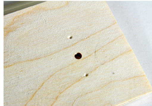
An der Markierung genau bohren – mit kleinerem Durchmesser beginnen
