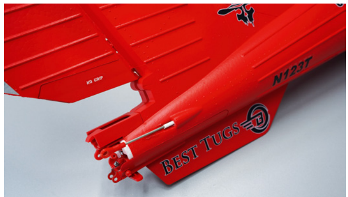
Die Montage von Höhenleitwerk und Spornrad samt Anlenkungen sind gut vorbereitet – die Anleitung erklärt ausführlich alle Schritte
