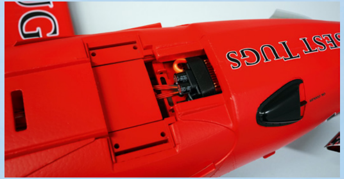
Bis 100 A Dauerbelastbarkeit verträgt der im Kühlluftstrom liegende Avian-Regler. Dank SMART-Technologie überträgt er Telemetriewerte
