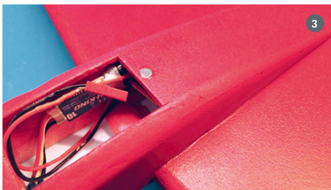
3) Das Akkufach bietet genügend Platz für LiPos bis zu einer Kapazität von 900 mAh.
