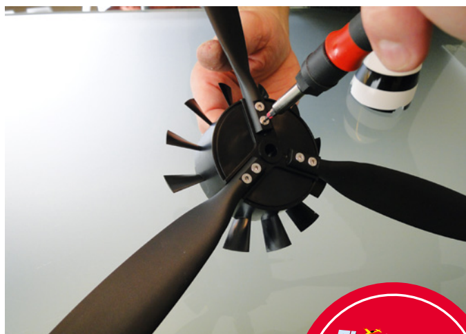
Der Propeller wird aus mehreren Einzelteilen zusammengeschaubt, das ist auch schon die aufwendigste Arbeit bei der Montage des Modells
