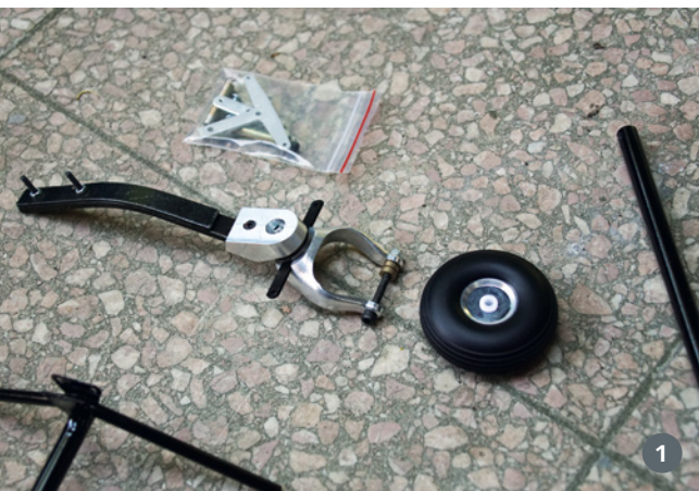
1) Das Spornrad ist blattgefедert. 2) Die Ballonreifen können mit Luft befüllt werden. Leider war diese Konstruktion ab Werk nicht dauerhaft dicht zu bekommen. 3) Die originalen Befestigungen der Tragflächenstreben (rechts) wurden gegen Exemplare mit Schnellverschlüssen getauscht
