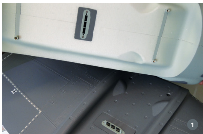
1) Beim Aufsetzen des Rumpfs auf den Flügel werden gleichzeitig auch die elektrischen Kontakte geschlossen – beim Außenflügel ist es identisch. 2) Die Oberfläche des Flügels ist schön gestaltet – Horizon Hobby beherrscht diese Technik sehr gut
