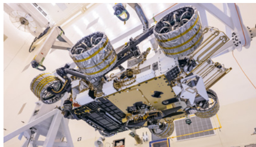
Perseverance von unten. Im Boden ist Ingenuity zu erkennen, die im Rover eingelassen ist und erst an ihrem Startplatz abgesetzt wird
