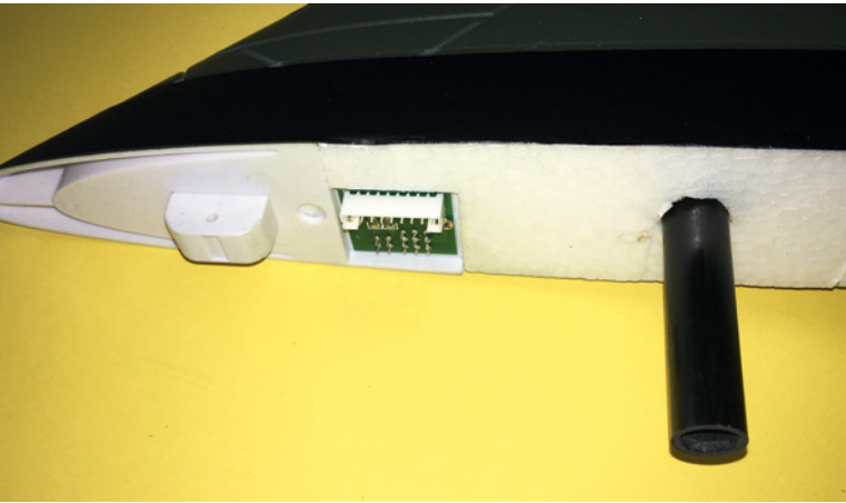
Links die Struktur für die Verschraubung der Tragfläche, dahinter die Platine für den Zentralstecker
