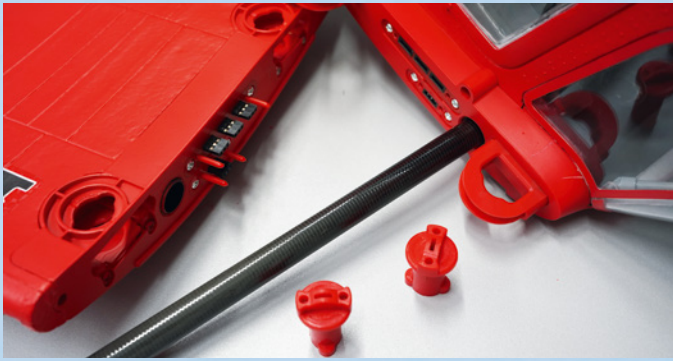
Massiver CFK-Holm, fertig konfektionierte Steckverbindungen und clevere Flächenbefestigung kennzeichnen den Wurzelbereich
