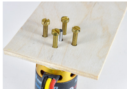
Abschließend die Öffnung für die Motorachse anpassen, damit der Spant gut aufliegt
