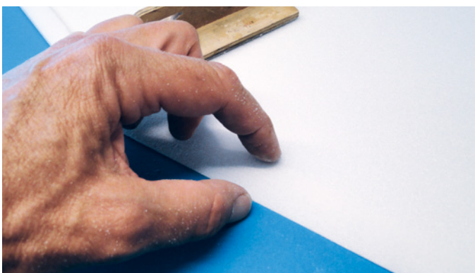
Auch die hinteren Enden der Beplankungen werden auf der Innenseite in einem Bereich von 15 mm abgeschliffen
