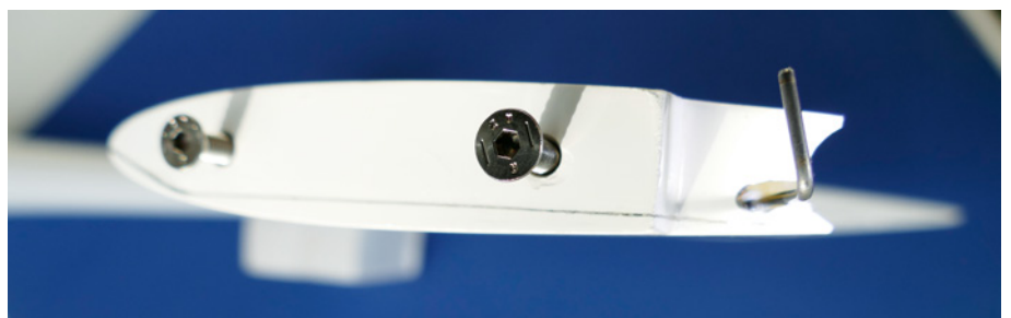
Blick auf die Höhenleitwerksauflage und die Anlenkung fürs Höhenruder – an dieser Stelle wurde zwecks EWD-Änderung später nasenseitig unterlegt
