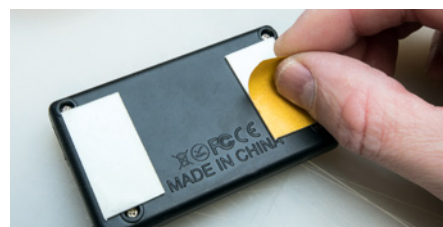
Spiegelklebeband sichert den LiPo-Checker auf der Senderrückseite
