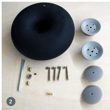
1) Das Spornrad ist blattgefедert. 2) Die Ballonreifen können mit Luft befüllt werden. Leider war diese Konstruktion ab Werk nicht dauerhaft dicht zu bekommen. 3) Die originalen Befestigungen der Tragflächenstreben (rechts) wurden gegen Exemplare mit Schnellverschlüssen getauscht
