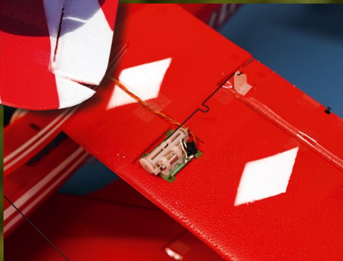
Sämtliche Linearservos für Höhen-, Seiten- und Querruder sind ab Werk betriebsbereit installiert
