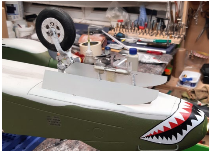
Im Auslieferungszustand gehören keine Fahrwerksklappen dazu. Sie wurden nachträglich eingesetzt
