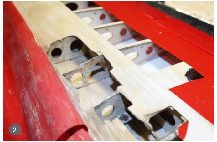
1) Das Loch im Flügel kündigt vom nahenden Unheil – hier haben Mäuse zugeschlagen. 2) Die Rippen sind teilweise zerfressen, die Beplankung ausgedünnt und das Holz hat Urin aufgesogen, die landkartenartige Fleckung beweist es. Der Schaden ist nicht unerheblich. Es stinkt ekelhaft
