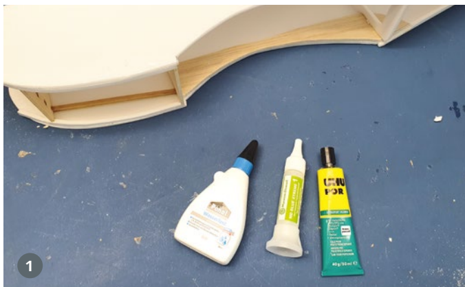
1) Weißleim, Uhu-Por und schaumstoffverträglicher Sekundenkleber sind geeignete Klebstoffe
