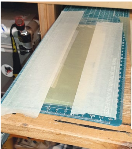
Als Material für den Klappenbau hat sich dünnes GFK optimal erwiesen, das passend zuzuschneiden war
