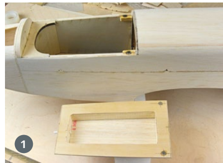
1) Der abgewandelte, stabilere Tankdeckel. 2) Damit das Seitenleitwerk etwas mehr seitlichen Halt bekommt, haben wir es zusätzlich in dem Höhenleitwerk verzapft
