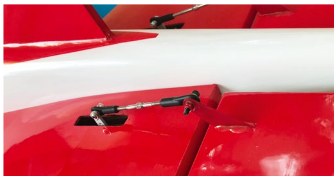
Die Servos für die Höhenruder sitzen direkt im Höhenleitwerk und ergeben extrem kurze und steife Anlenkungen. Hier sind GFK-Ruderhörner statt der beiliegenden Kunststoffteile eingeklebt
