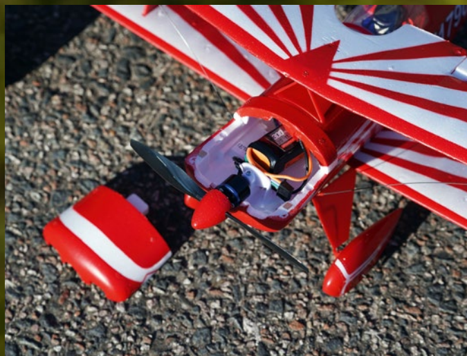
Zum Betrieb des kraftvollen Brushless-Motors eignen sich 2s- und 3s-LiPos mit 300 mAh Kapazität
