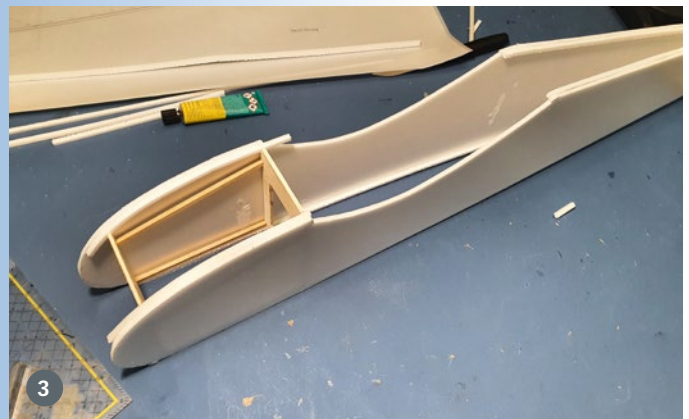
3) Beim Zusammenbau des Rumpfs liegt die gerade Oberseite auf dem Baubrett auf
