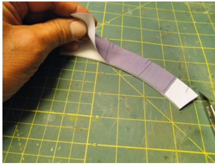
Die mit Sprühkleber auf Depron geklebten Papiere lassen sich mühelos wieder entfernen
