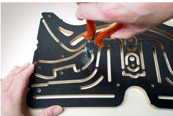
Mit einem Seitenschneider sind die Stege der gefrästen Holzteile zu trennen
