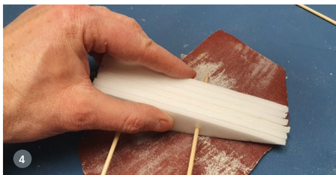
4) Die sechs Rippen lassen sich leicht im Block bearbeiten und werden geteilt
