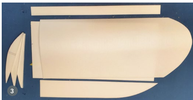
3) Der Flügel wird aus einer überschaubaren Anzahl von Einzelteilen aufgebaut
