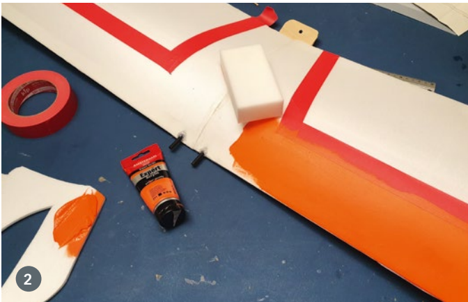
2) Acrylfarbe aus der Tube, ein Schmutzradiererschwamm und gutes Maskierband sind ideal zum Lackieren
