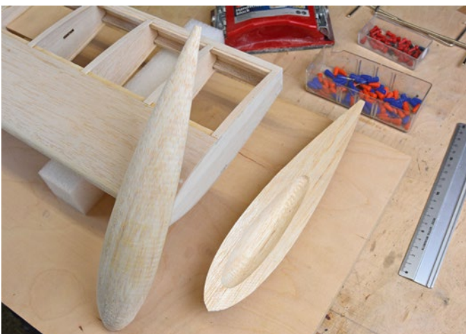
Mit Anbringen der Nasenleiste und der vorkonfektionierten Randbögen ist der Rohbau abgeschlossen
