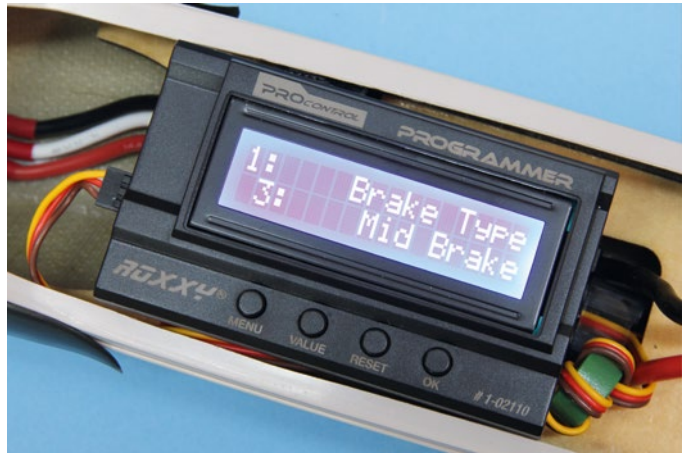
Die oberste Zeile des Programmers zeigt jeweils den Parameter, der eingestellt wird
