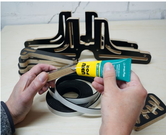
Etwas Uhu Por erhöht die Haftkraft der selbstklebenden Moosgummistreifen
