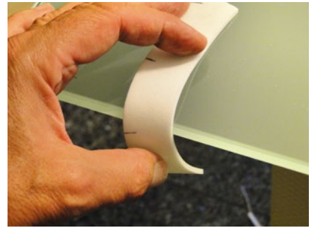
Über eine Tischkante werden die Teile in Form gewalkt – hier ein Ring der Motorogndel
