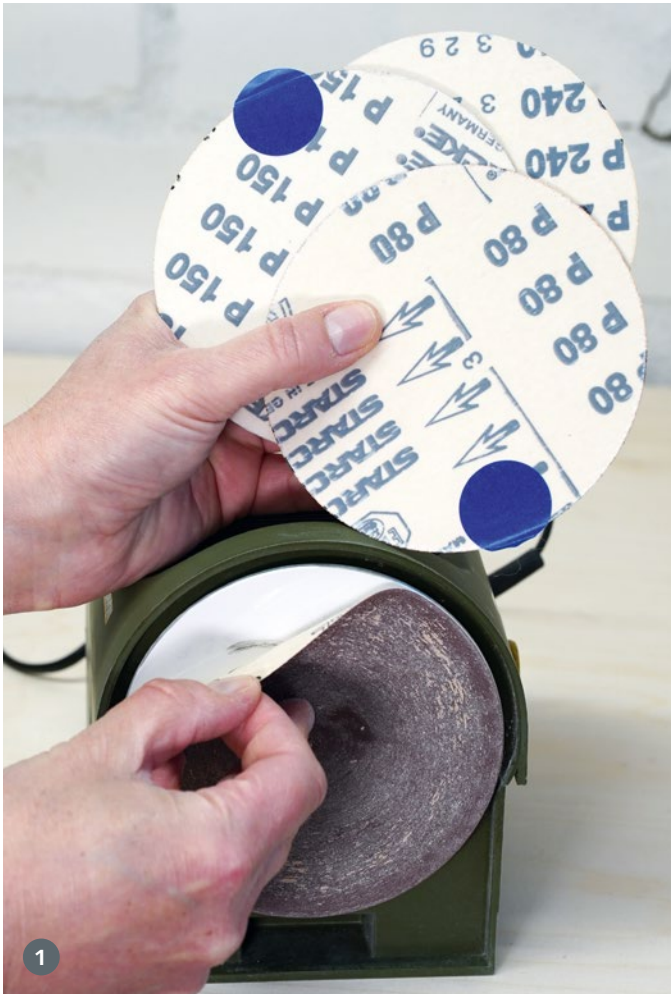
1) Dank Silikonbeschichtung lassen sich Schleifscheiben einfach lösen und mehrfach verwenden. 2) Über den Drehregler passt man die Rotationsgeschwindigkeit und damit Schleifcharakteristik an. 3) Schutzbrille, Gehörschutz und Staubmaske sind ein absolutes Muss bei Einsatz des TG 125/E
