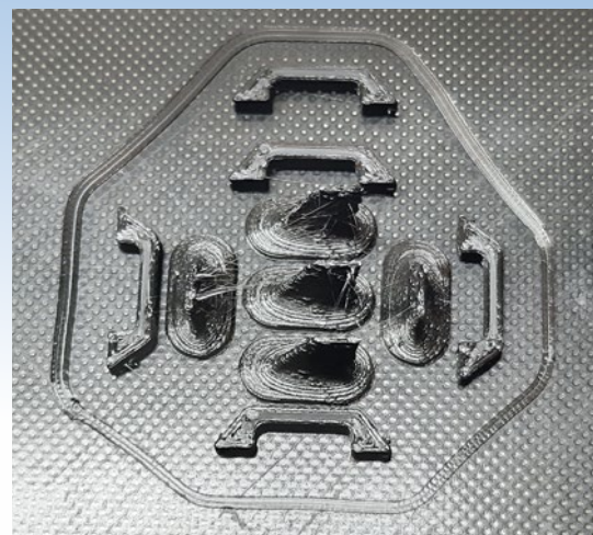
Mit Hilfe eines 3D-Druckers entstanden Kleinteile wie diese Handgriffe, die unterhalb der Glaskanzel Platz fanden
