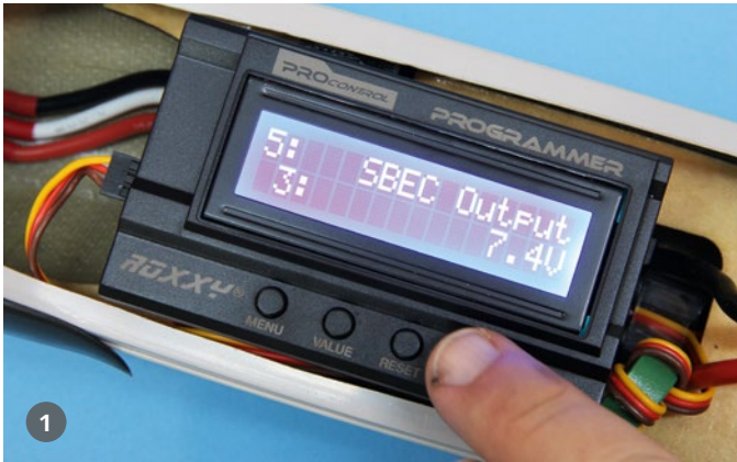
1) In der unteren Zeile finden sich die jeweiligen Einstellwerte. Der Programmer ist eine sinnvolle Ergänzung für den Regler. 2) Um die Stabilität der Empfängerstromversorgung zu prüfen, wurde der Infinity sowohl mit einem UniSense für die Antriebsdaten, als auch mit dem Unilog zur Erfassung der Empfängerstromversorgung ausgerüstet
