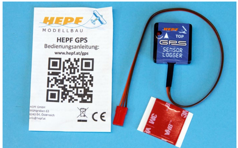
Neben dem eigentlichen GPS-Logger werden ein Stück doppelseitiges Klebeband mitgeliefert und ein QR-Code, der auf die Anleitung verweist
