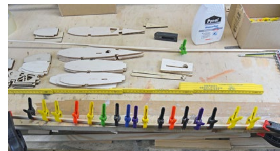
Bei der Erstellung der Gurte für Haupt- und Hilfsholm muss sorgfältig gearbeitet werden
