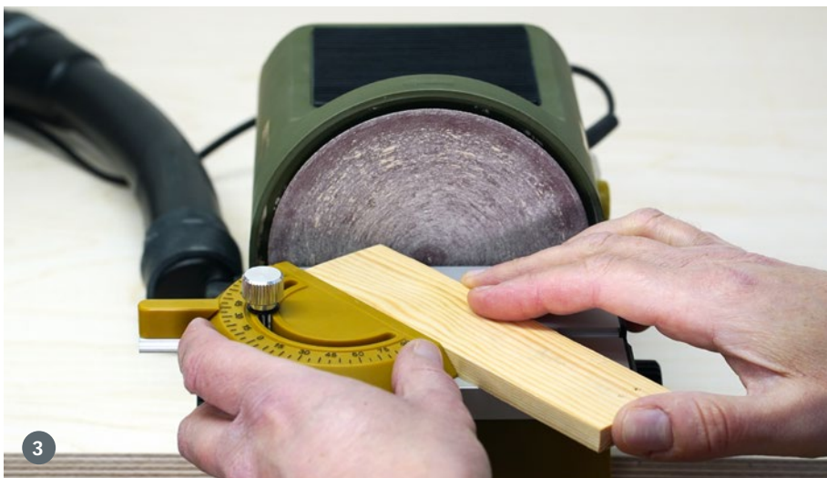
1) Unter Zuhilfenahme von Hilfswerkzeugen, hier ein festgeklebtes Brett, kann man lange Schrägen zum Schäften schleifen. 2) Absolut kreisrunde Scheiben gelingen unter Verwendung einer Hilfsvorrichtung. 3) Mit Anschlagwinkel sind Schrägen zwischen 1° und 89° beziehungsweise rechte Winkel umsetzbar
