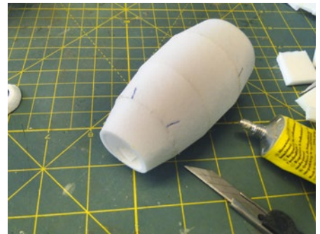
So fügen sich die einzelnen Segmente zum kompletten Bauteil und sind lediglich noch zu schleifen
