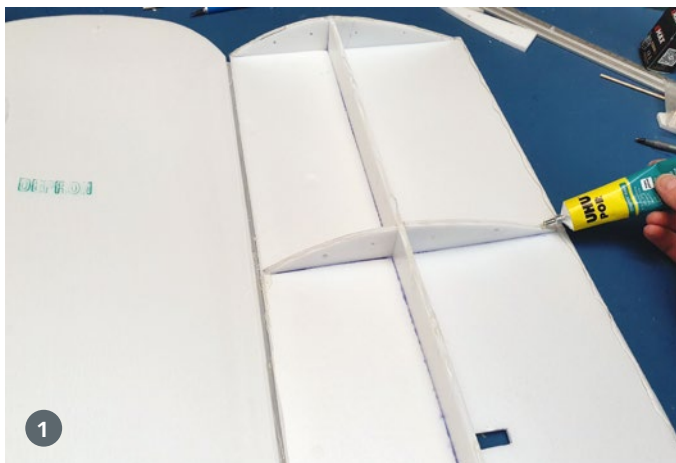
1) Unter- und Oberseite sind mit Hilfe von Leisten und Geduld auf Rippen, Holm und Endleiste zu kleben
