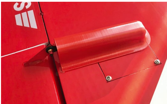
Für die Querruder- und Landeklappen-Anlenkungen wurden selbstkonstruierte Hutzen in 3D-Druck erstellt
