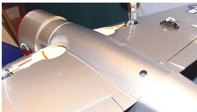
Wer die Flächenhälften verklebt, kann auch die Bauchabdeckung an die Flügel kleben – alternativ ist Festschrauben möglich
