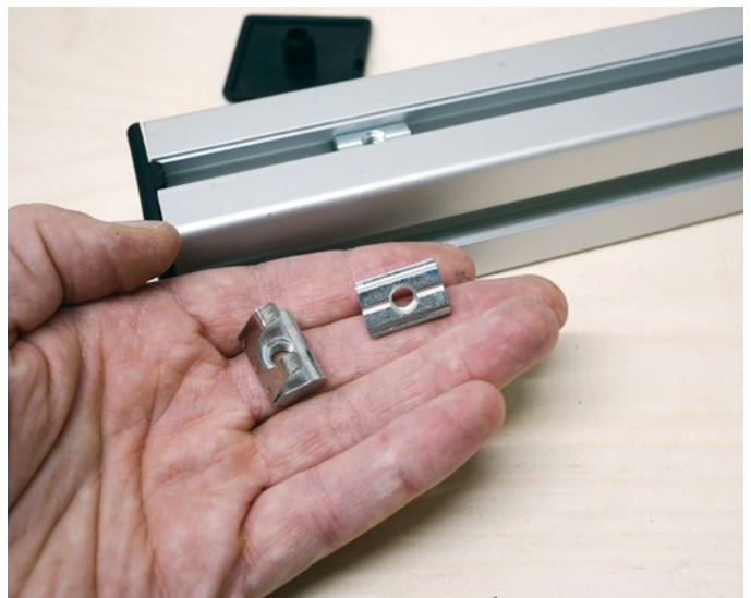
Geheimnis der Flexibilität sind ins Aluprofil eingeschobene Nutensteine mit Gewinde
