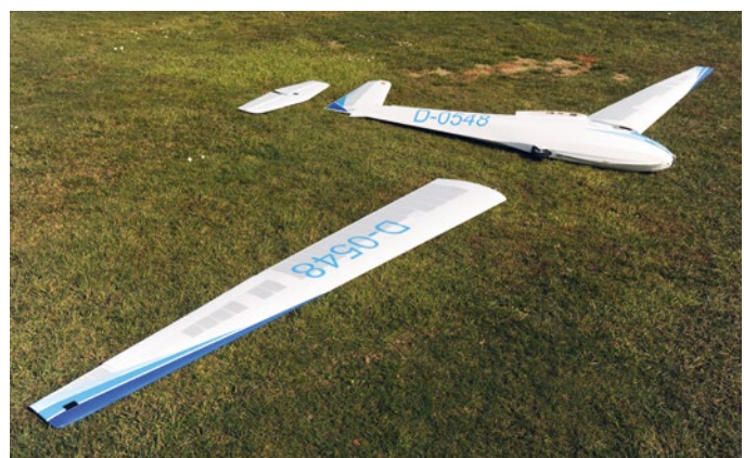
Mit einem Packmaß von maximal 2,45 m in Bezug auf die Flügelänge ist die K8b in größeren Pkw transportierbar
