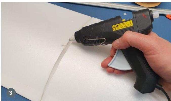
3) Zum Verkleben der Flügelhaften eignet sich Heißkleber, aber auch Weißleim oder Uhu-Por
