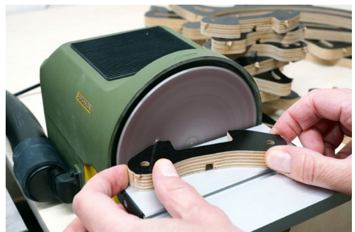
Beim Entgraten war der Proxxon-Tellerschleifer eine wertvolle Stütze
