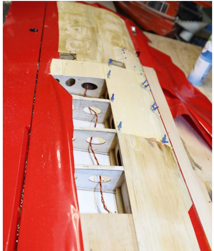
Parallel zum Aufbringen der Beplankung und vor dem erneuten Bebugeln, wurden die benötigten Servokabel eingezogen
