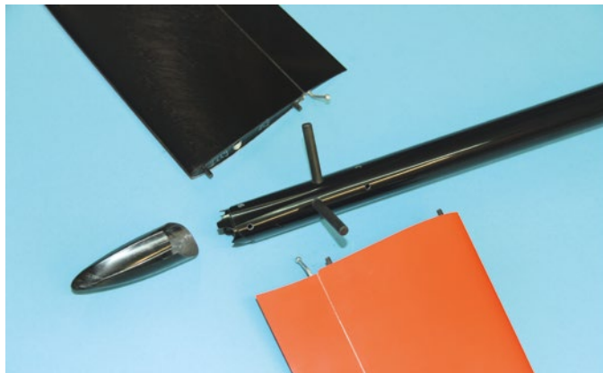
Die Steckungen im Bereich des V-Leitwerks sind flugfertig erstellt, ebenso die Anlenkungen. Einstecken und sichern, Kugelköpfe einklipsen, fertig
