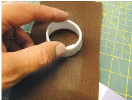
Das Segment der Motorogndel wird oben und unten sorgfältig plangeschliffen
