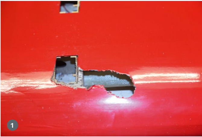
1) Das Loch im Flügel kündigt vom nahenden Unheil – hier haben Mäuse zugeschlagen. 2) Die Rippen sind teilweise zerfressen, die Beplankung ausgedünnt und das Holz hat Urin aufgesogen, die landkartenartige Fleckung beweist es. Der Schaden ist nicht unerheblich. Es stinkt ekelhaft
