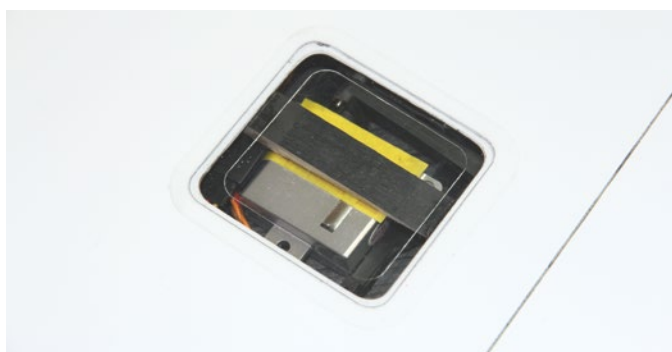
Die eingebauten Servos werden über zusätzliche CFK-Plättchen zur Flügelunterseite hin nochmals abgestützt
