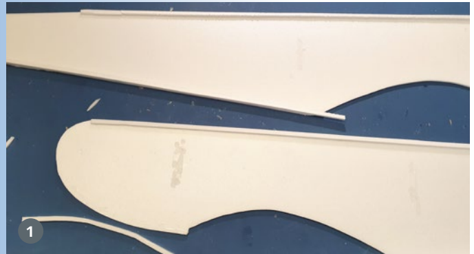
1) Depronleisten in den Ecken des Rumpfs dienen später zum Abrunden der Kanten
