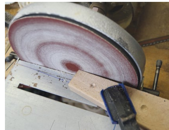
Diese einfache Schleifvorrichtung hilft bei der Herstellung einer haltbaren Schäftung ungemein
