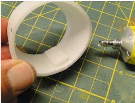
Mit Uhu-Por wird das Teil zu einem Ring verklebt, eine Lasche sorgt für eine stabile Verbindung
