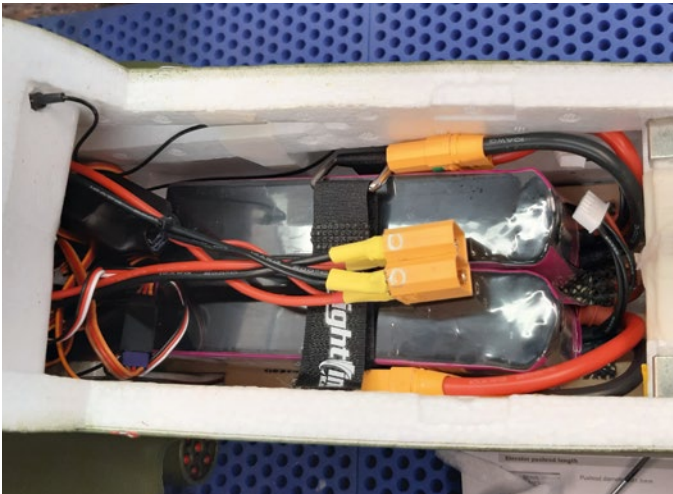
Ausgerüstet mit zwei 4s-Akkus á 3.800 mAh Kapazität sind 10 Minuten Flugzeit möglich
