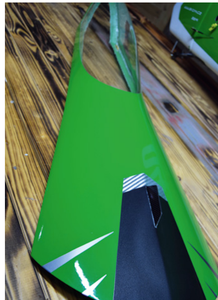
Im Rumpheck sind zusätzlich kleine Entlüftungsschlitze eingelassen
