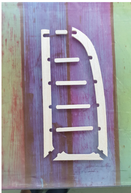
Die Ruder werden aus CNC-gefrästen Teilen auf einer Platte zusammengepuszelt
