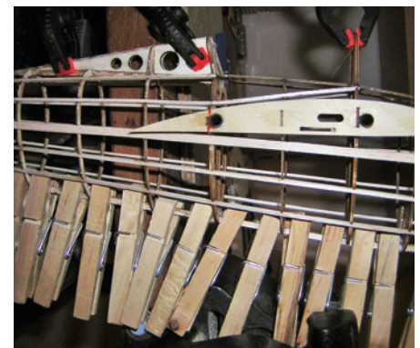
Für die Zusammensetzung der beiden Rumpfhälften sollten viele Wäscheklammern zur Verfügung stehen
