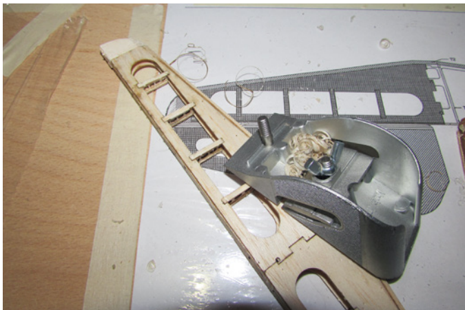
Mit einem feinen Balsahobel lassen sich Profile, Rundungen und Schrägen gezielt erstellen
