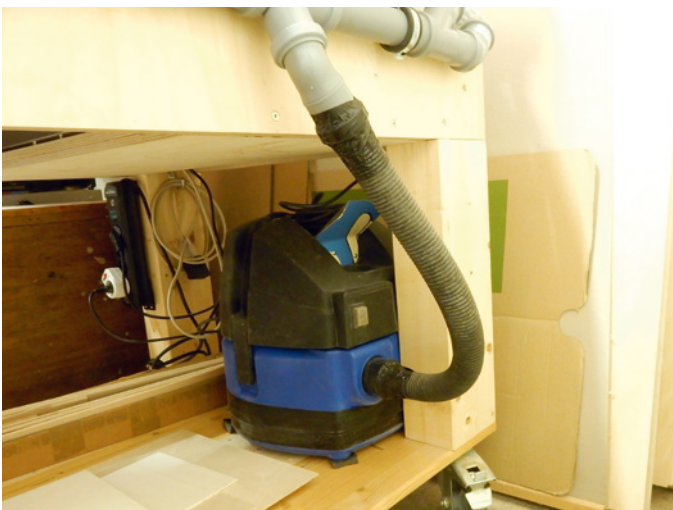
Unter der Maschine und am Tisch verschraubt, steht der modifizierte Staubsauger fürs Ansaugen
