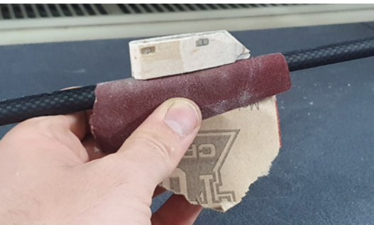
Der Pylon für das Höhenleitwerk besteht aus einem Balsa-Sperrholz-Balsa-Sandwich. Zur Anpassung kann das Schleifpapier einfach um den Kohlefaserstab gewickelt werden
