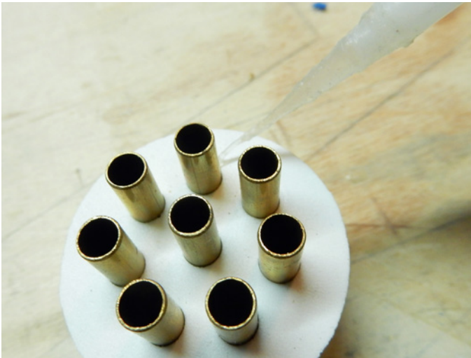
Diese Adapterstücke leisten hierzu gut Dienste, müssen aber noch mittels Sekundenkleber verklebt werden
