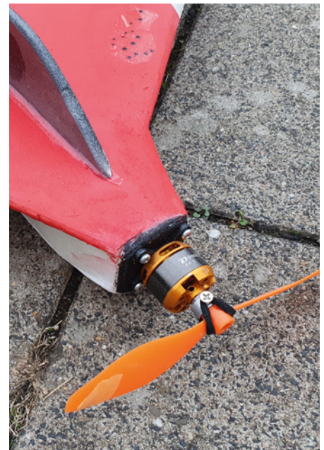
Der Propsaver macht Sinn beim Combatfliegen. Er rettet aber eher die Motorwelle als die Propeller
