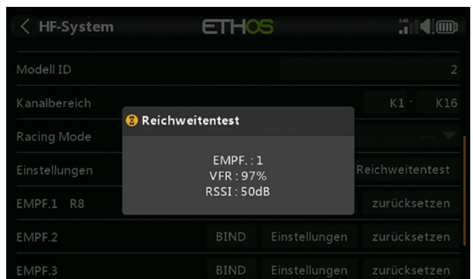
Reichweitentest: Alle Werte bleiben bei der geforderten Distanz absolut im grünen Bereich
