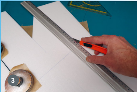
3) Die Tailerons werden in einem Stück in einem Winkel von etwa 30° abgeschnitten. Gewichte sorgen dafür, dass der frisch eingeklebte Flügelholm gerade liegt und das Backpapier verhindert, dass Flügel und Gewichte verkleben. 4) Uhu Por ist das Mittel der Wahl für flächige Depronklebungen wie hier, wenn das obere und untere Flügelteil miteinander verklebt werden. 5) Bewährt hat sich, die Nasenleiste mit einem Cutter oder einem sehr scharfen Küchenmesser in Form zu schnitzen
