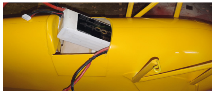
In Bezug auf die Akkurutsche wurde der Bausatz modifiziert, damit der 4S-LiPo bequem platziert werden kann
