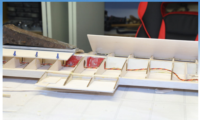
Der über 4 m spannende Rippenflügel wird vollflächig mit Balsa beplankt – das war beim Vorgänger nicht so
