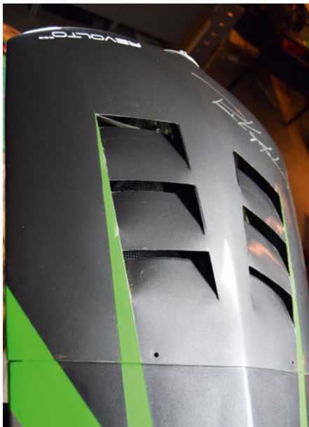
Im Rumpheck sind zusätzlich kleine Entlüftungsschlitze eingelassen
