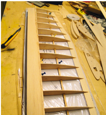
Klassischer Flügelbau: Dank der Frästeile eine schnelle Sache
