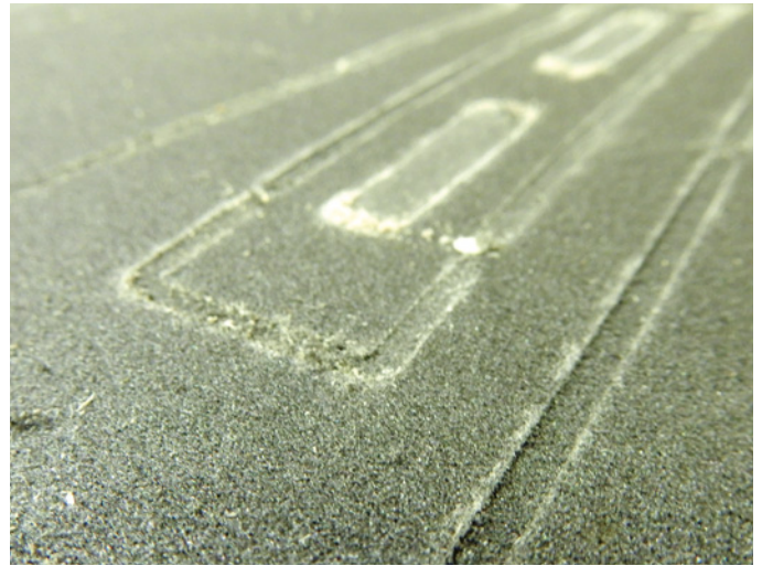
Fräsbahnen im Opfermaterial. Ich lasse den Fräser für ein sauberes Fräsergebnis 0,3 mm unterhalb des Werkstücks hervorstehen
