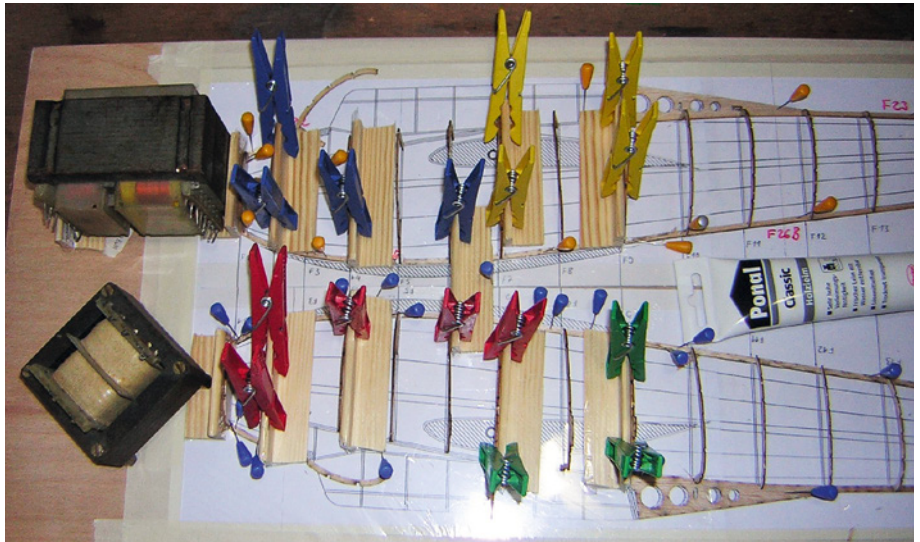
Mit den Winkelleisten entstand ein ideales Werkzeug zur senkrechten Fixierung der Rumpfhalspanten
