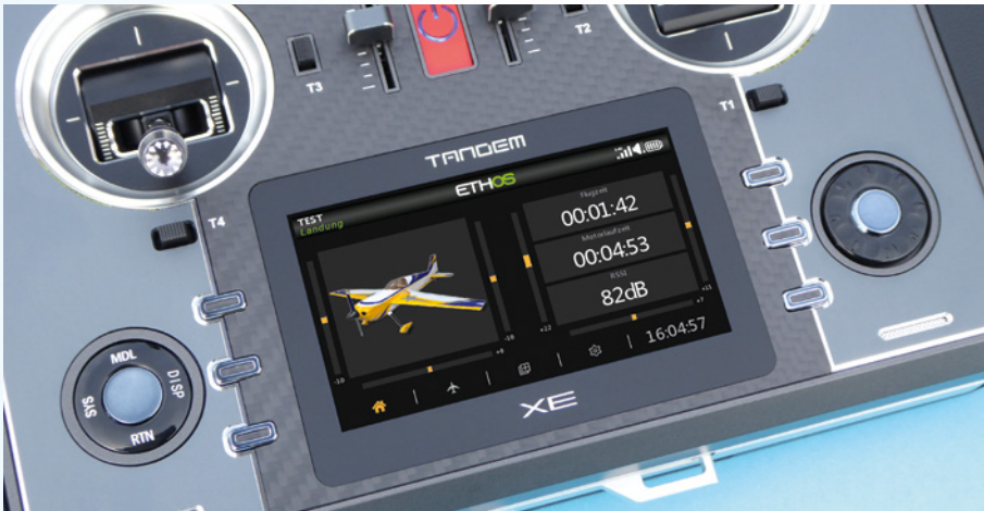
Die Kommunikation mit dem Sender ist sowohl über den Touchscreen, als auch über die Bedientasten möglich
