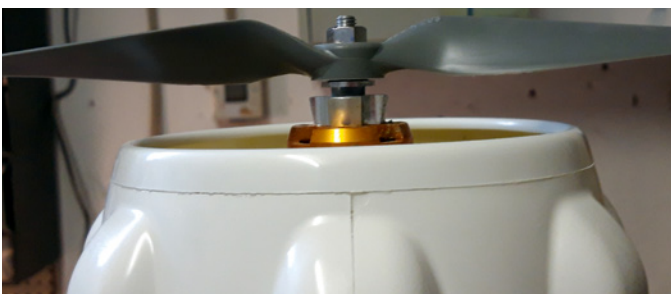
Zwischen Propeller und Haube ist mehr als genug Platz
