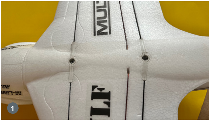
1) Die Tragflächen werden mit zwei M5-Schrauben am Rumpf befestigt. Hier wurden die Nylon- durch Metallschrauben mit Innensechskant ersetzt. 2) Hier ist genug Platz für verschiedene Akkugrößen, um die Position variieren und somit den Schwerpunkt einstellen zu können
