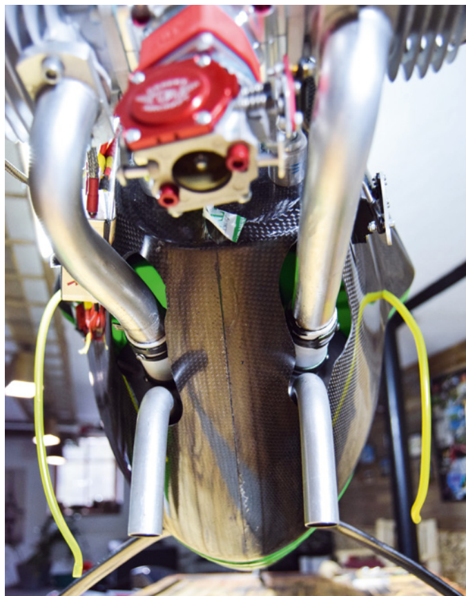
Zum Gebrauchtmotor gehörten auch Pefa-Resorohre und -Krümmer, die sich perfekt in Motorhaube und Rumpf der Revolto integrieren ließen
