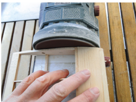
Die Wurzelrippen der Flügel müssen für die korrekte V-Form angeschrägt werden, ein Tellerschleifer mit Winkelanschlag leistet gute Dienste
