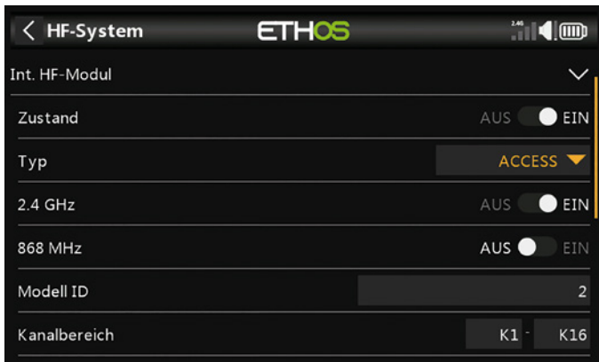
Im Untermenü „HF-System“ erfolgt die Konfiguration der beiden Funkstrecken 2,4 GHz und 868 MHz
