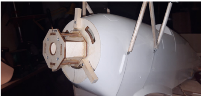
6 x 6-mm-Kiefernholzleisten stützen die GFK-Motorhaube. Sturz und Seitenzug des Motors werden durch die gelaserten Teile exakt vorgegeben
