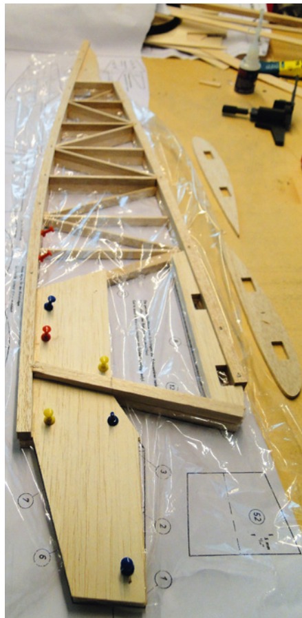
Bau eines Seitenteils des Rumpfs direkt auf der Bauplan-Kopie
