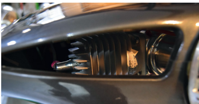
Kühlluft fließt reichlich über die Kühlrippen – hier bietet das markante Design vermutlich zusätzliche Vorteile
