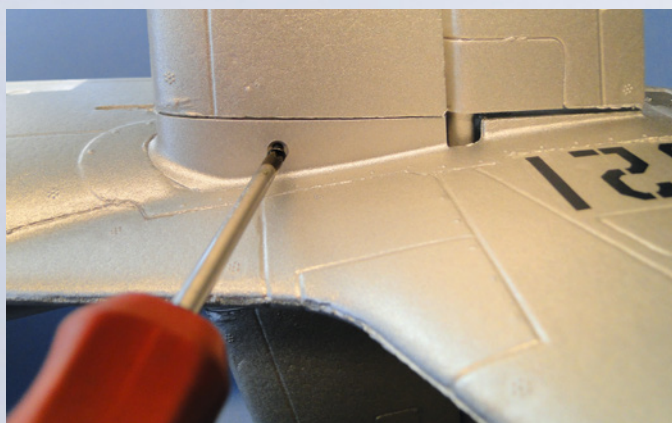
Selbstschneidende Schrauben sichern die Leitwerkshälften
