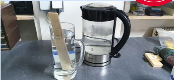
Der untere Rumpfboden und die Haube werden ein paar Minuten gewässert und anschließend über Nacht fixiert
