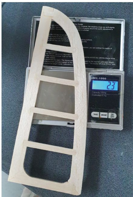
Mit Hobel und Schleifplatte lässt sich die Endleiste am besten bearbeiten – das Ergebnis ist ein 23 g leichtes Seitenruder
