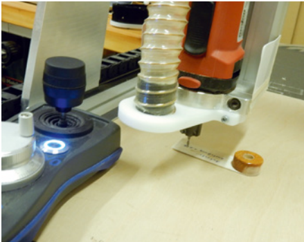
Der Antaster wird auf das Werkstück gelegt und so lange hin- und herbewegt, bis der Fräser anschnäbelt
