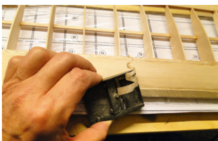
Mit dem Balsaobel lässt sich die Nasenleiste schnell in Form bringen, für den Feinschliff kommt Sandpapier zum Einsatz
