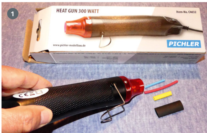
Nur 220 mm lang und etwa 170 g leicht ist das 300-W-Heißluftgebläse von Pichler
