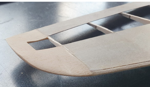
Die Kontur des Randbogens ist bereits aus 6-mm-Balsa gefräst, er muss nur noch profiliert werden
