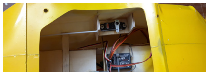
Simple und effektiv sind die Servohalterungen. Die Bowdenzüge sind am Rumpf abzustützen
