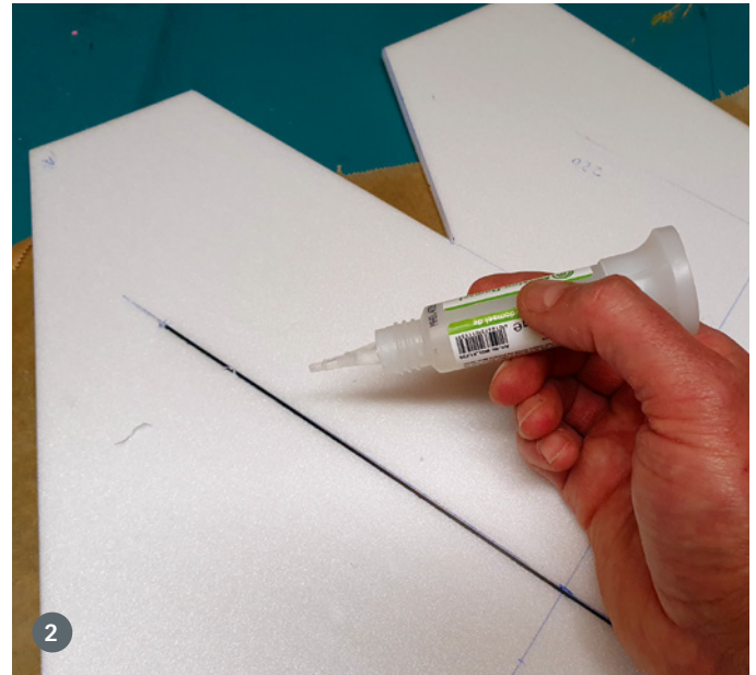
1) Die Teile für das Modell lassen sich dank gerader Kanten sehr zügig ausschneiden. Für den Holm wird ein 1 mm breiter Schlitz in die Flügelgrundplatte geschnitten. 2) Mit schaumstoffverträglichem Sekundenkleber wird der Holm verklebt
