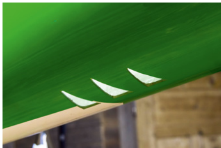
Im Rumpheck sind zusätzlich kleine Entlüftungsschlitze eingelassen
