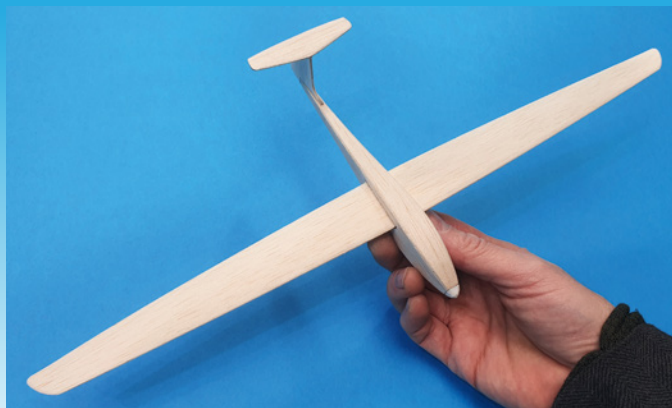
Für einen Feinschliff kann man die Rumpfkanten anschrägen und die Flügel sowie das Leitwerk profilieren. Von den Flugeigenschaften her muss es aber nicht sein
