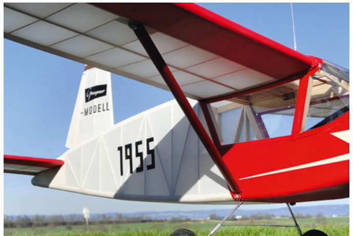
Die Flügelstreben sind mit M4-Stehbolzen, Muttern und Alublechen befestigt
