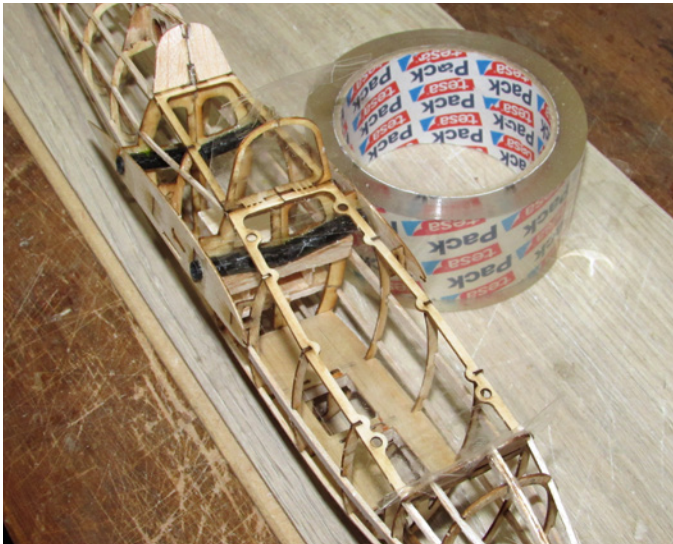
Die Kabinenhaube entsteht direkt auf dem mit transparentem Klebeband beschichteten Rumpf
