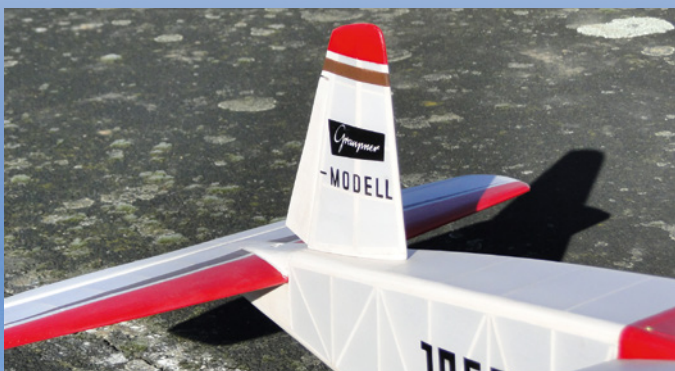
Höhen- und Seitenruder sind unsichtbar angelenkt
