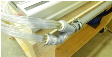
Alle Schläuche sind mit den HT-Rohren verbunden, die seitlich am Tisch befestigt werden
