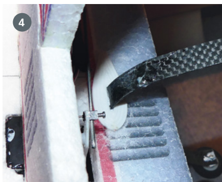
Ein glatt durchgebrochener CFK-Fahrwerksbügel eines Indoor-Modells wurde noch vor Ort stumpf verklebt und danach mit einem beidseitigen Booster-Auftrag verstärkt. Das hält sehr gut
