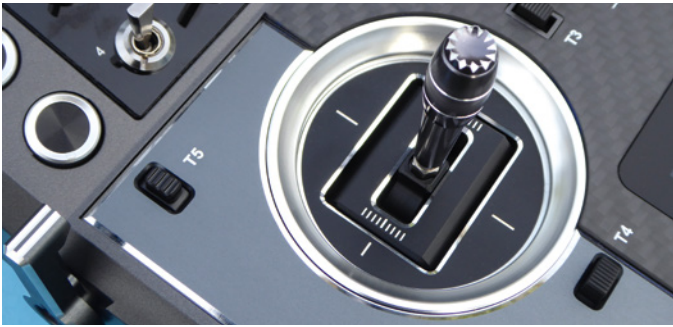
Die kugelgelagerten, präzisen Steuerknüppel sind mit Hall-Sensorik ausgestattet
