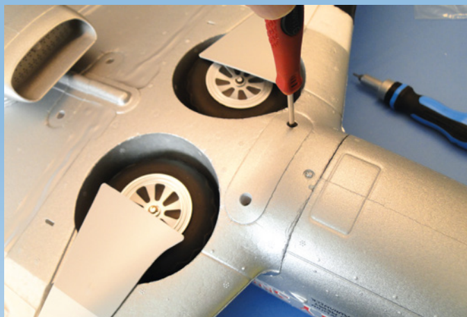
Erst mit einem extra langen Inbus-Schraubendreher lassen sich die Flächenschrauben eindrehen
