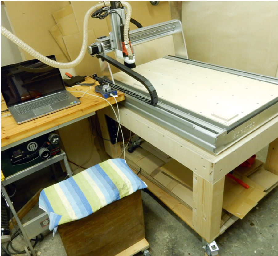
Der PC-Arbeitsplatz sollte sich in der Nähe der Maschine befinden und die Maschine sollte gut zugänglich und auf einem stabilen Tisch installiert sein
