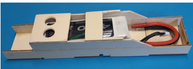
Zum Lieferumfang gehören auch Bauteile für einen Akkuschacht, der jedoch für NiCd-Akkus gedacht und für LiPos damit etwas zu groß ist
