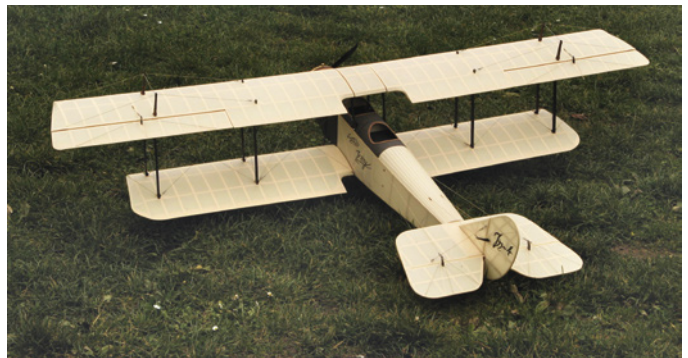
Abbildung 8: Die Curtiss Jenny mit 1.800 mm Spannweite und vorbildgetreuer Rumpflänge hat ein im Vergleich zum Original um 50% vergrößertes Höhenleitwerk – es fällt kaum auf
