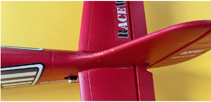
Kleiner Kritikpunkt beim Testmuster: Die Verpackung scheuerte am Seitenleitwerk. Aufgrund der Verwendung von Metalleffektlack ist das nur schwer auszubessern
