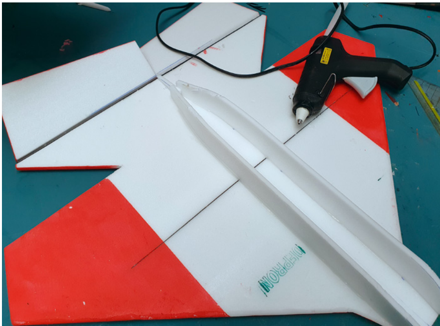
Die Rumpfsseitenwände werden einfach unter den Flügel geklebt. Ist dieser vollflächig lackiert, muss das zuvor geschehen
