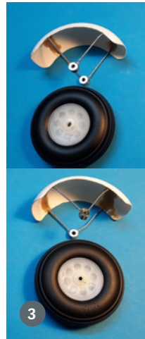
1) Auf dem Baubrett werden obere und untere Tragfläche mit dem Winkelmesser und Positionierungshilfen exakt eingestellt. 2) Ein Modell im Modell ist das etwas aufwendiger zu fertigende Fahrwerk. 3) Die Radhauben liegen als Zubehör bei. Etwas tricky ist die Montage der Drähte mit den Stellringen. 4) Die Flächenstreben definieren den Abstand und Winkel. Gut zu sehen ist die Flächenbauweise mit Aufleimern
