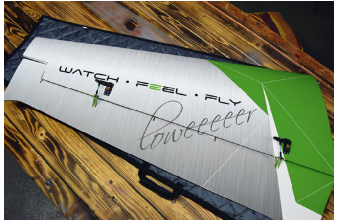
Zwei Servos, die synchron arbeiten, sind pro Flügel erforderlich – schließlich sind alleine die Ruder fast so groß wie die gesamte Tragfläche mancher normalen Modelle
