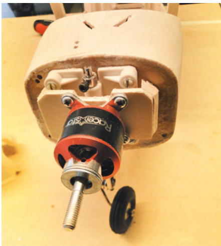
Der Motor sitzt auf einem kleinen Vorbau, das Bugfahrwerk direkt dahinter
