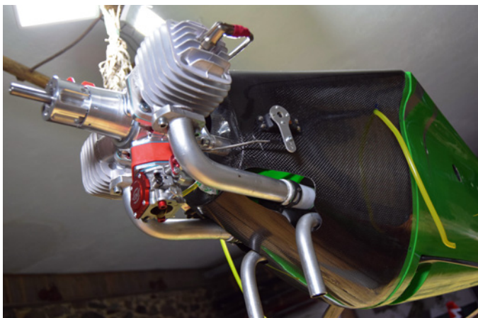
Ein DA120 passt optimal zur Revolto. Unter 100 cm 3 Hubraum sollte man keinesfalls gehen
