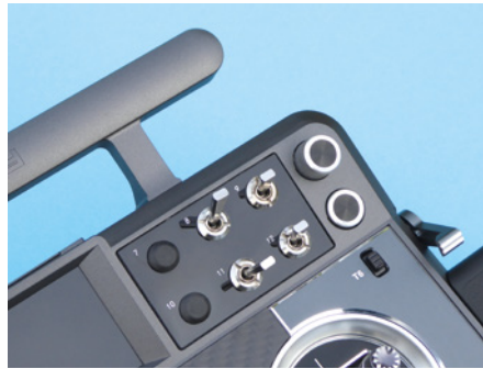
Die Schalterbänke sind mit jeweils vier Schaltern bestückt, die Drehgeber lassen sich versenken
