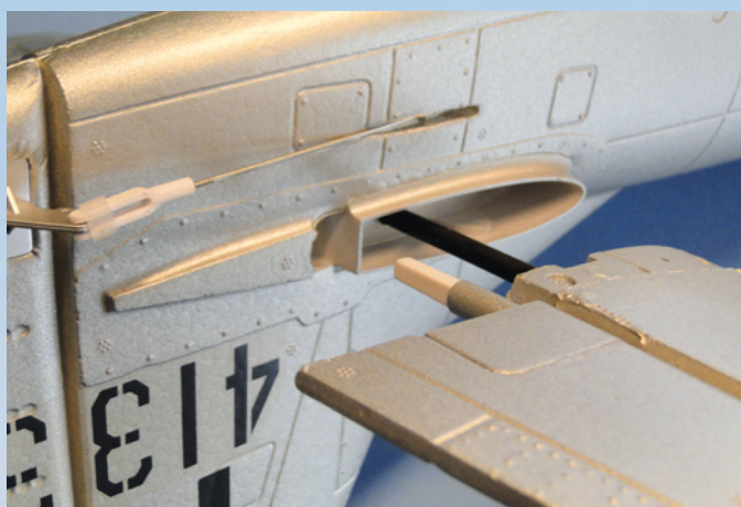
Die Höhenleitwerkshälften werden nach bewährter Manier zusammengesteckt
