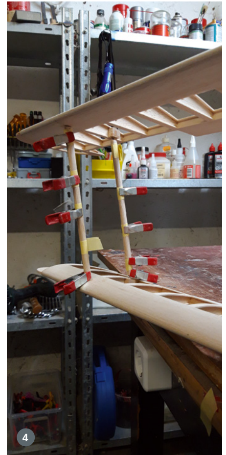
1) Auf dem Baubrett werden obere und untere Tragfläche mit dem Winkelmesser und Positionierungshilfen exakt eingestellt. 2) Ein Modell im Modell ist das etwas aufwendiger zu fertigende Fahrwerk. 3) Die Radhauben liegen als Zubehör bei. Etwas tricky ist die Montage der Drähte mit den Stellringen. 4) Die Flächenstreben definieren den Abstand und Winkel. Gut zu sehen ist die Flächenbauweise mit Aufleimern
