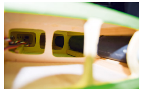
Sowohl Flächen als auch Leitwerke und alle Ruder sind in vollbeplankter Rippenbauweise ausgeführt und foliert
