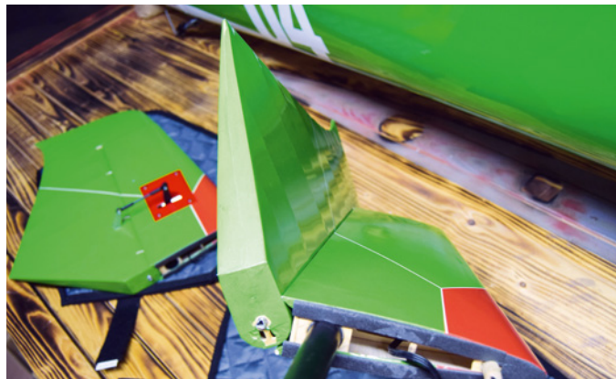
Große Ausschläge und kaum nennenswerte Spalten. Konstruktiv ist das sehr gut umgesetzt
