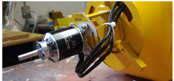
Den actro-Motor kann man sehr gut auf dem Dom befestigen. Wie sich später zeigte, ist der aber noch zu verstärken
