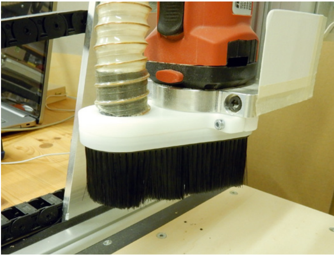
Der Absaugschuh ist unverzichtbar, wenn man an seiner Fräsmaschine lange Freude haben möchte und die Werkstatt nicht nach jeder Fräsaktion grundreinigen möchte
