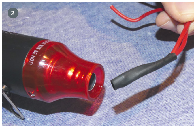
Durch den ausklappbaren Ständer lässt sich das Heißgebläse auch freihändig betreiben
