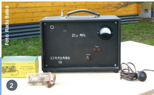
1) Antik-Servo: So ein Schrittschaltwerk saß früher direkt unter dem Seitenruder der Electra. Es wurde von einem Gummimotor angetrieben. 2) Der Einkanalsender von 1955 wog 6,5 kg und kostete ein durchschnittliches Monatsgehalt, genau wie der Empfänger war er mit Röhren bestückt. 3) So sah die Werkstoffpackung der Electra aus. Die Teile waren nur aufgedruckt, mussten noch alle selbst aus ausgesägt werden
