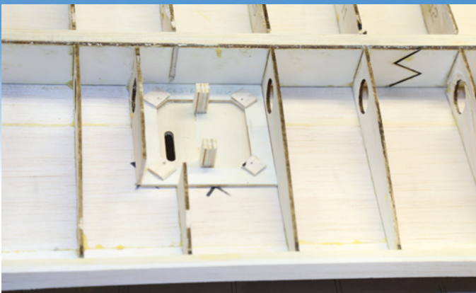
Für den Servoeinbau ist ein Rahmen für die Servoplatte vorgesehen
