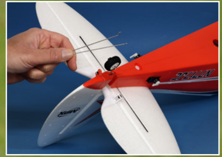
Vor dem Einhängen der Gestänge sollte man die Servohebel in Neutralstellung bringen
