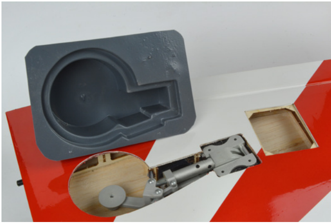
Die Hauptfahrwerke passen exakt in die entsprechenden Aufnahmen. Vorher muss der Fahrwerksschacht zugeschnitten und verklebt werden
