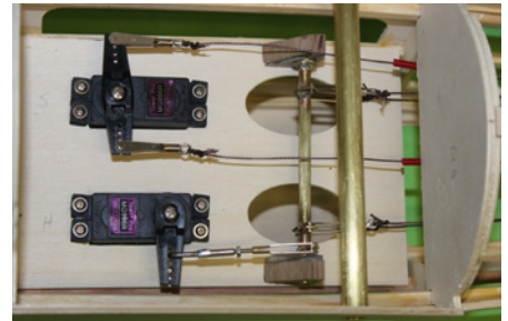
Das Praktische an der Etrich Taube ist, nur zwei Servos zu benötigen
