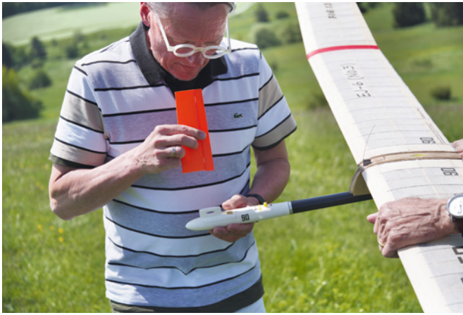
Für die Elektronik von Paul Seren druckte Bernhard Pach eine passende Flosse, die er hier aufsteckt
