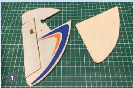
1) Aus 4-mm-Sperrholz wird eine konturengleiche Kopie des Unterteils der Finne erstellt und geschliffen. 2) Von einer PET-Einwegflasche werden Boden und Oberteil abgeschnitten. 3) Das Sperrholzteil wird in das Mittelteil der Flasche geschoben, um mit der Heißluftpistole den Kunststoff in die gewünschte Form zu bringen
