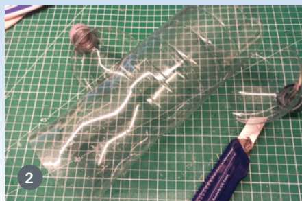
1) Aus 4-mm-Sperrholz wird eine konturengleiche Kopie des Unterteils der Finne erstellt und geschliffen. 2) Von einer PET-Einwegflasche werden Boden und Oberteil abgeschnitten. 3) Das Sperrholzteil wird in das Mittelteil der Flasche geschoben, um mit der Heißluftpistole den Kunststoff in die gewünschte Form zu bringen
