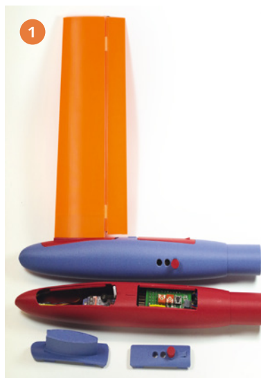
1) Die neue Seren-Steuerung in einem Rumpfkopf von Bernhard Pach – einmal waagrecht, einmal senkrecht eingebaut. Der weiße Stift in der roten Version ist der Mitnehmer für das Ruderblatt. 2) Das Turbulenz-Profil der gedruckten Flosse veröffentlichte der Schweizer Max Moor 1963. Diese Flosse fliegt unter anderem Jean-Luc Drapeau (FRA), F1E-World Cup-Gesamtsieger 2023
