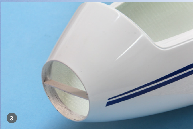
1) Durch den bei FW erhältlichen SpezialsSpinner fñgt sich der FES-Antrieb optimal in die Rumpfkontur ein. 2) Der Rumpf ist ab dem Kabinenhaubenausschnitt nach hinten großflächig mit CFK verstärkt. 3) Bestellt man den Cirrus mit FES-Vorbereitung, so ist die Rumpfschnauze bereits abgetrennt und vorne entsprechend verstärkt und mit einem später zu entfernenden Stützkeil versehen. 4) Das zweiteilige und gedämpfte Höhenleitwerk wird betriebsfertig ausgeliefert und bedarf keinerlei Restarbeiten
