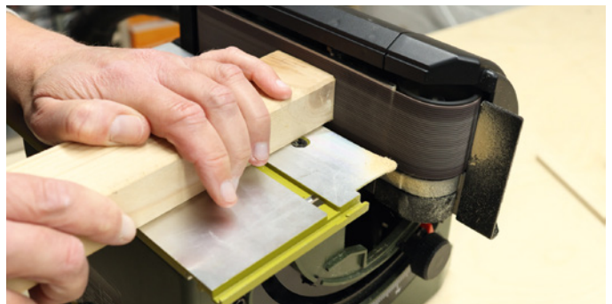
50 mm ist das Schleifband breit, sodass auch größere Holzstücke gut zu bearbeiten sind
