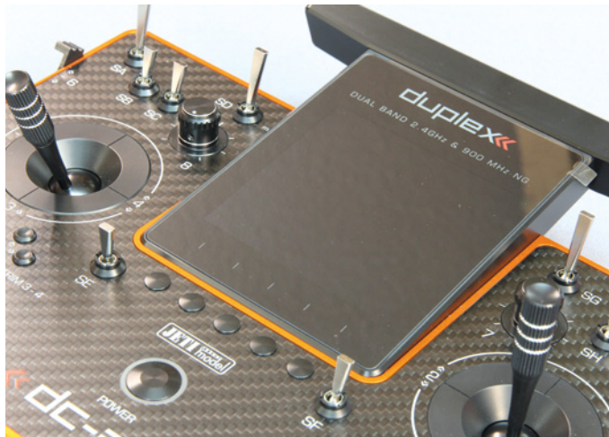
Das neue Display ragt nun bis zum Antennenhalter. Es ist deutlich größer, schärfer und zum Piloten hin geneigt
