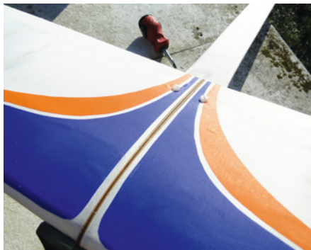
Beim Einsatz des Falko ohne Motor ersetzt eine Mittelrippe den Motoraufsatz
