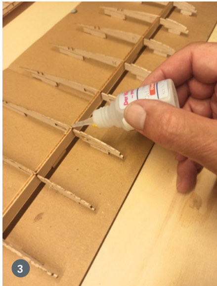
1) Auf Kante gelasert: An den Rippen berühren sich teilweise die Schnittkanten. 2) Das führt schnell mal zu Bruch, lässt sich aber wieder kleben. 3) Abweichend von der Anleitung kam hauptsächlich Sekundenkleber beim Bau zum Einsatz. 4) Aus optischen Gründen wurde das Servokabel nicht, wie vorgesehen, im offenen Bereich des Flügels verlegt, sondern unsichtbar in der D-Box
