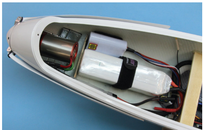
Vorne im Rumpf sitzt nun alles, was schwer ist. Der Spant hinter dem Antriebsakku ist die Auflage für die Sitzwanne
