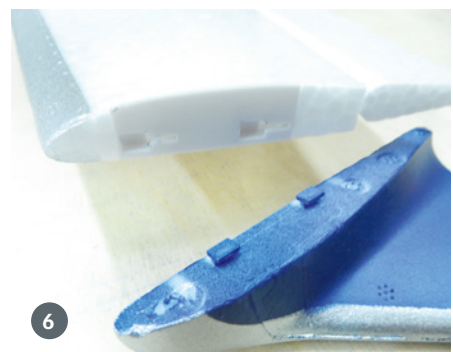
4) Der kleine 2.400er-Akku findet seinen Platz ganz vorne auf dem langen Akkubrett, um den richtigen Schwerpunkt einstellen zu können. 5) Die Tragwerksaufnahme am Rumpf erfolgt über eingeformte Kunststoffhalterungen. 6) Tolles Detail: die Winglets sind über einen passgenauen Bajonettverschluss mit dem Flügel verbunden
