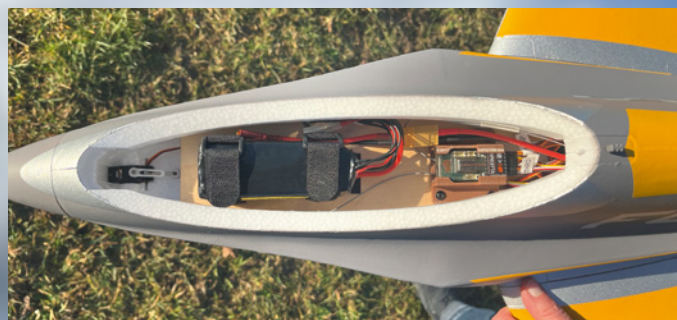
Über die abnehmbare Kabinenhaube ist der Innenraum gut zugänglich. Um den Schwerpunkt einzuhalten, lässt sich die Position über das Akkugewicht einstellen
