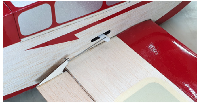
Die Querruderanlenkung liegt gut geschützt über dem Flügel. Durch einen abgekröpften 0,8-mm-Stahldraht werden die Ruder mit zwei Servos direkt angelenkt
