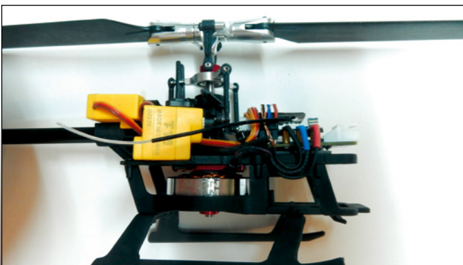
Gesteuert wird die Taumelscheibe von kräftigen Digitalservos
