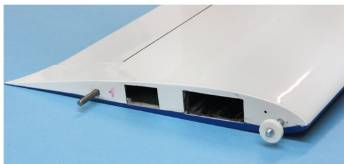
Auch der Tragflächenanschluss und die Flächenbefestigung per Rändelschraube sind bei FW Models ab Werk fertiggestellt
