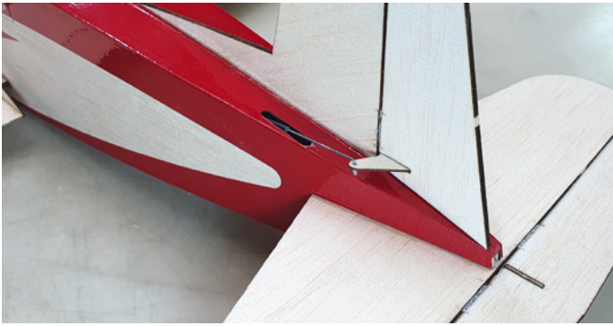
Höhen- und Seitenruder werden mit leichten Schubgestängen angesteuert. Das ist simpel, leicht und besonders in dieser Modellgröße spielfrei
