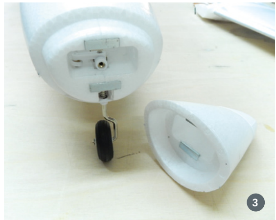
1) Das gefederte Hauptfahrwerk ... 2) ... sitzt in sehr stabilen Fahrwerksaufnahmen im Flügel. 3) Unter der abnehmbaren Nase ist die Anlenkung des ebenfalls gefederten Bugfahrwerks versteckt
