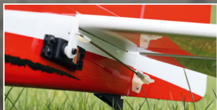
In der BNF-Version sind Servos und Gestänge ab Werk betriebsbereit installiert
