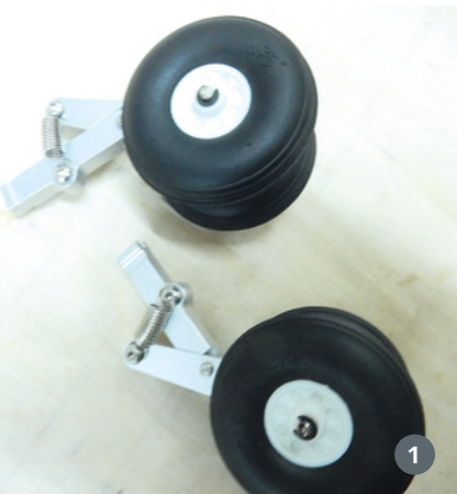
1) Das gefederte Hauptfahrwerk ... 2) ... sitzt in sehr stabilen Fahrwerksaufnahmen im Flügel. 3) Unter der abnehmbaren Nase ist die Anlenkung des ebenfalls gefederten Bugfahrwerks versteckt
