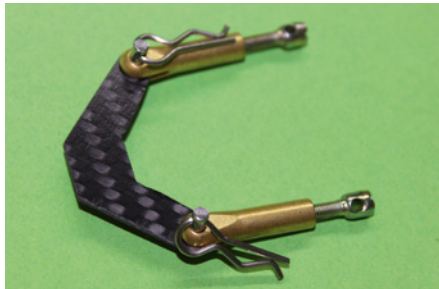
Ruderhorn für das Seitenruder aus CFK und mit Anlenkung über Seile
