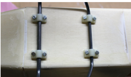
Stabile Befestigung der Fahrwerksdrähte über Kunststofflager am Rumpfboden
