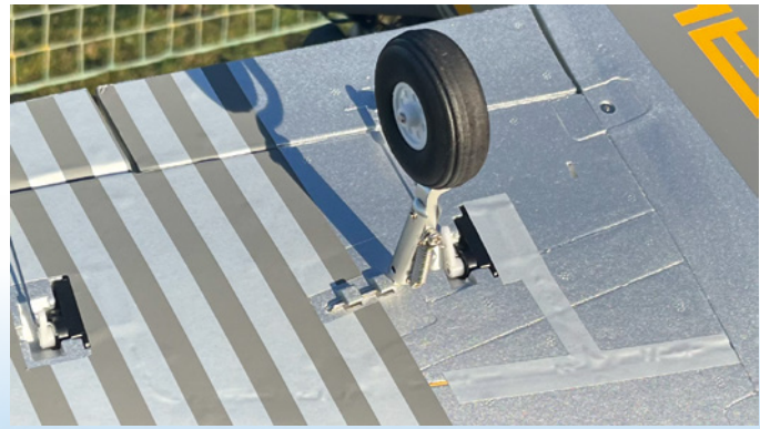
Die Federbeine verfügen über Schwingen; leider gibt es bei der kleinen Futura kein Einziehfahrwerk
