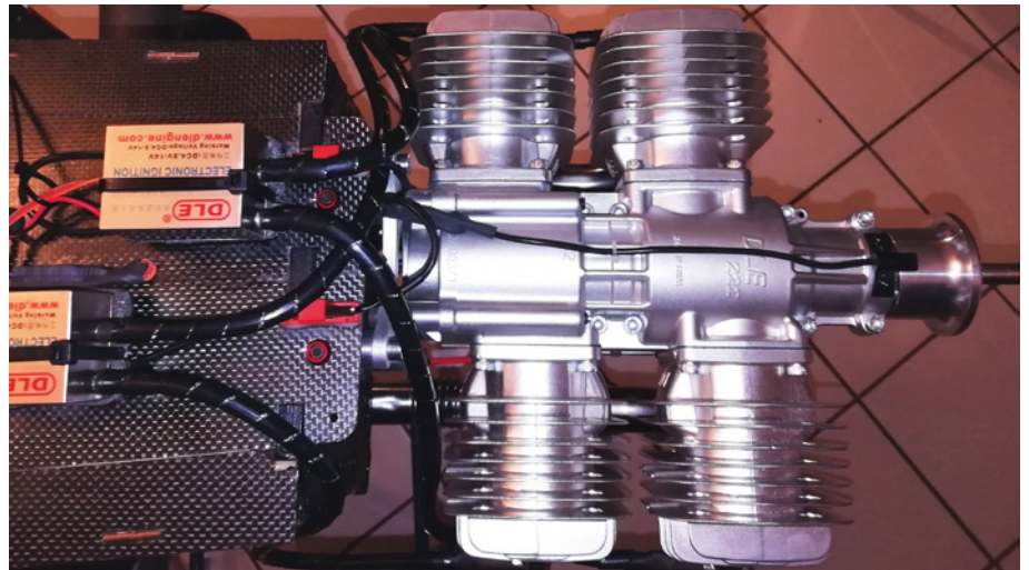
Ganz gleich, ob Elektro oder Verbrenner, auf Zuverlässigkeit, Leistung und Geräuschniveau kommt es an. Hier zu sehen ist der von Frank Köhler eingesetzt DLE Vierzylinder mit 220 cm 3 Hubraum und etwa 21 PS Leistung
