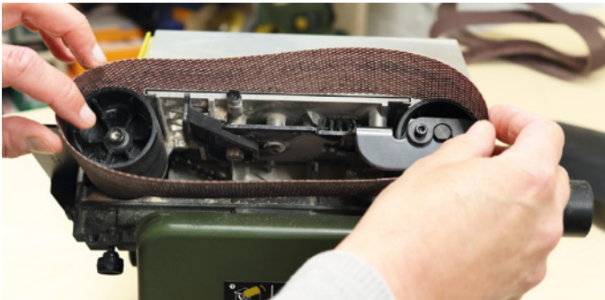
Zum einfachen Schleifbandwechsel sind zwei Kunststoffwannen zu demontieren und ein Spannhelb zu lösen. In welche Richtung man das Band einspannt, spielt keine Rolle
