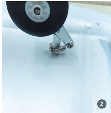
1) Das gefederte Hauptfahrwerk ... 2) ... sitzt in sehr stabilen Fahrwerksaufnahmen im Flügel. 3) Unter der abnehmbaren Nase ist die Anlenkung des ebenfalls gefederten Bugfahrwerks versteckt
