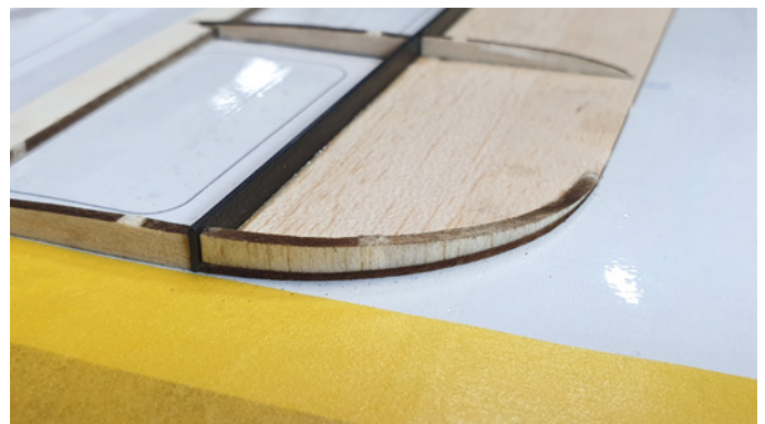
Am gerundeten Randbogen wird eine Rippe nass gemacht, vorsichtig gebogen und dann, noch feucht, mit Sekundenkleber an Ort und Stelle aufgesetzt
