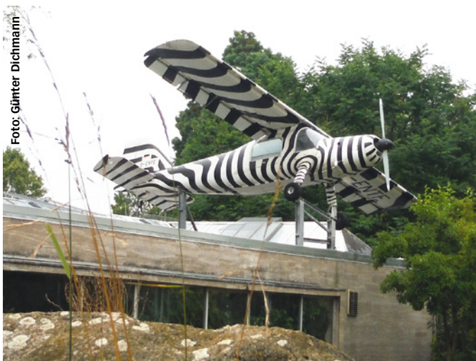
Abbildung 10: Die Dornier Do-27 – hier das legendäre Exemplar der Familie Grzimek im Frankfurter Zoo – ist ein typisches STOL-Muster mit starren Vorflügeln
