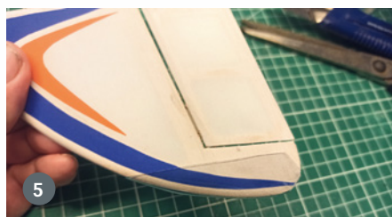
4) Nach dem Beschneiden des PET-Teils hält man den transparenten Landesporn in der Hand. 5) Mit zwei, drei Tropfen transparentem Kleber befestigt (Canopy Glue von Krick), fällt der Sporn nicht weiter auf und schützt jetzt die Finne. 6) Landen auf der PET-Kufe bleibt künftig für den Falko von aero-naut folgenlos. Das Prinzip lässt sich auch auf andere Modelle übertragen
