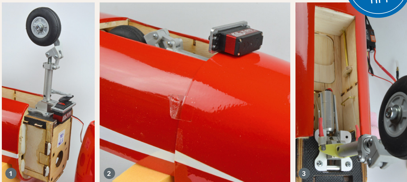
1) Die direkte Anlenkung des Bugfahrwerks ist im ausgefahrenen Zustand nicht zu beanstanden 2) Aber in der Gear up-Position kann die Konstruktion nicht überzeugen 3) So sieht die Anlenkung des Bugfahrwerks nach dem Umbau aus. Nur über eine Seilanlenkung und anderweitige Platzierung des Servos lässt sich das lösen
