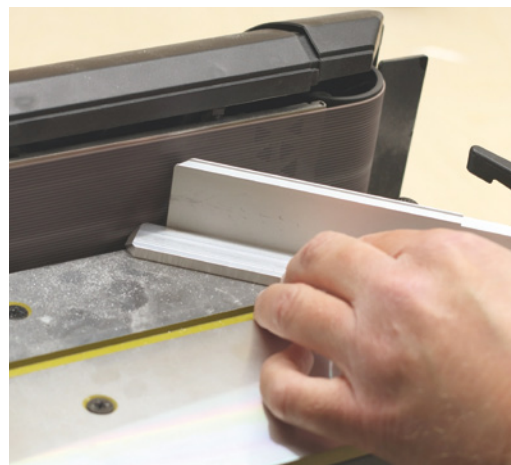
Alu lässt sich genauso gut und mit feinem Schliffbild bearbeiten wie andere Materialien
