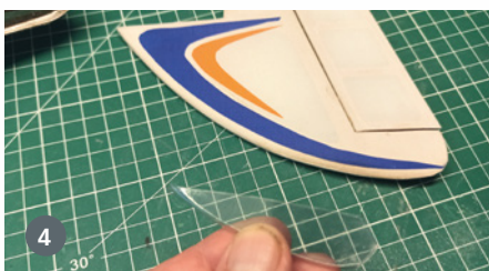
4) Nach dem Beschneiden des PET-Teils hält man den transparenten Landesporn in der Hand. 5) Mit zwei, drei Tropfen transparentem Kleber befestigt (Canopy Glue von Krick), fällt der Sporn nicht weiter auf und schützt jetzt die Finne. 6) Landen auf der PET-Kufe bleibt künftig für den Falko von aero-naut folgenlos. Das Prinzip lässt sich auch auf andere Modelle übertragen
