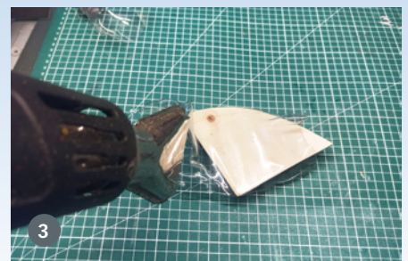
1) Aus 4-mm-Sperrholz wird eine konturengleiche Kopie des Unterteils der Finne erstellt und geschliffen. 2) Von einer PET-Einwegflasche werden Boden und Oberteil abgeschnitten. 3) Das Sperrholzteil wird in das Mittelteil der Flasche geschoben, um mit der Heißluftpistole den Kunststoff in die gewünschte Form zu bringen
