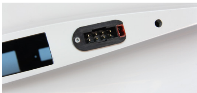
Für die drei Flächenservos wurde ein achtpoliger Stecker vorgesehen. Strom für die Beleuchtung liefert der angesetzte Stecker
