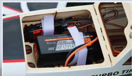
Einfacher Akku-Zugang über die Motorhaube – auch gut zum Einstellen der Schwerpunktlage
