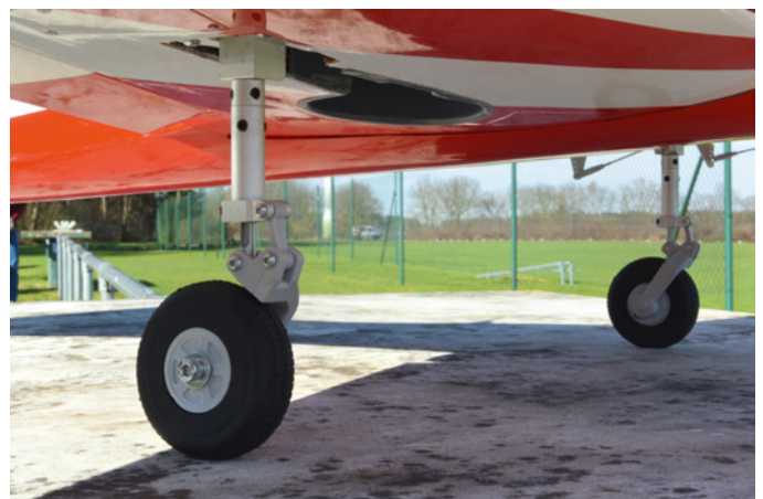
Das Hauptfahrwerk ist für das Flugzeug ausreichend dimensioniert
