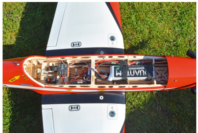
Der 5.000er-Akku muss weit nach hinten, sonst ist die Tucano kopflastig
