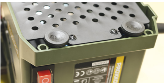
Nicht erfasster Staub kann unten durch die Gehäuseplatte fallen. An vier Punkten lässt sich das sicher stehende Gehäuse zudem mit Schrauben fixieren
