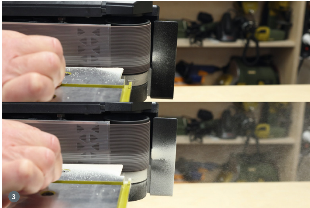
1) Das Netzschleifband Abranet der Mark Mirka – in 100er-, 180er- und 240er-Körnung – ist durchlässig für Schleifstaub. 2) Um Schleifstaub durch das Netzschleifband zu saugen, sind im massiven Rollentisch Löcher eingelassen. 3) Bei aktiver Staubabsaugung (oben) wird feiner Schleifstaub effektiv durchs Netzschleifband und die Tischlöcher abgesaugt, wie der Vergleich gegenüber deaktivierter Absaugung (unten) zeigt – der Staubnebel ist beträchtlich
