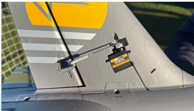
Das Seitenruderservo ist ebenfalls bereits eingebaut und das Ruder angeschlossen
