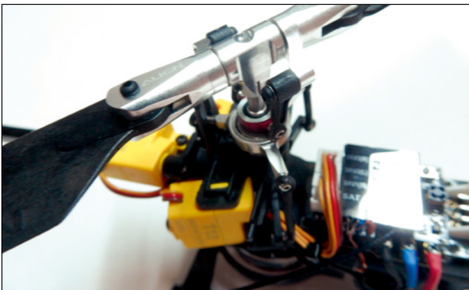
Der traumhaft gemachte Alu-Rotorkopf mit der darunterliegenden Taumelscheibe
