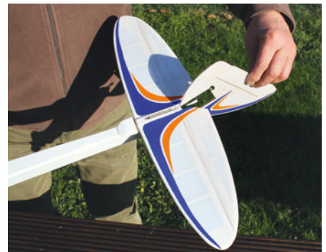
Höhen- und Seitenleitwerk des Falko lassen sich ohne Werkzeug komplett entfernen, das macht ihn transportfreundlich
