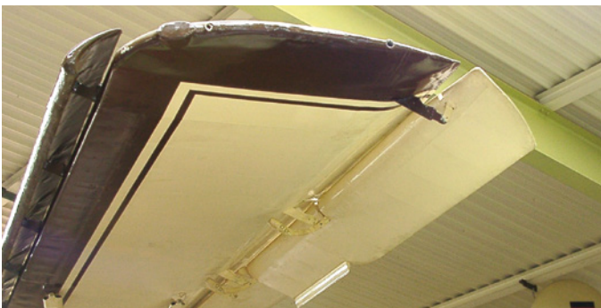
Bild 8: Der Vorflügel beim Fieseler Storch erzeugt eine Lücke im Profil
