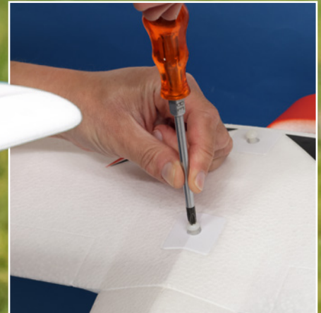
Solide Sicherung der Flächen über Nylonschrauben, die in Gewinde im Rumpf greifen
