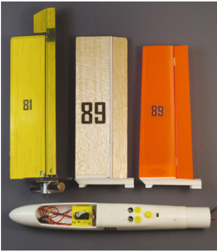
Das Ruder über dem Magneten (links) benötigte noch eine Ausgleichsfläche („Ruderhorn“). In der Mitte Ruder und Flosse aus 3-mm-Balsa mit spaltfreiem Scharnier. Darunter Seren-Steuerung PS V 0.9 in einem Gehäuse von Bernhard Pach
