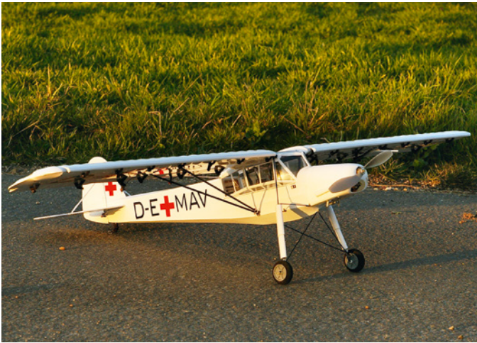
Abbildung 2: Das langbeinige gut gefederte Fahrwerk des Storchs fängt Stöße bei harten Landungen gut ab und gab dem Original seinen Spitznamen
