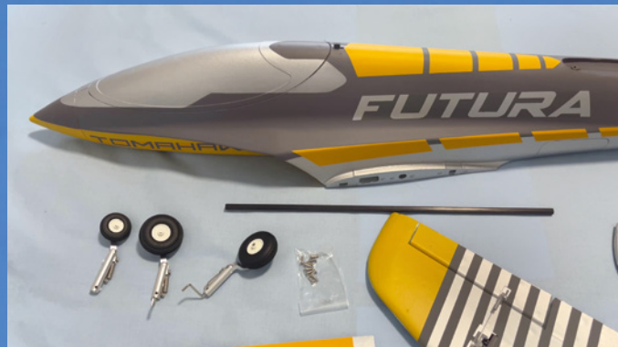
Die FMS Futura 64 von D-Power kommt nahezu komplett montiert aus der Verpackung. Zusätzlich werden nur noch Akku und Empfänger benötigt
