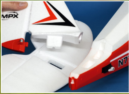
Zapfen, Nuten und Führungen halten beide Leitwerke an vorgegebener Position
