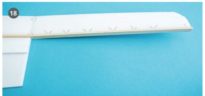
18 Mit Weißbleim setzen wir die fertig vorbereiteten Depron-Flügelbauteile an den Holm an und fixieren sie dort mit kreuzweise gesetzten Stecknadeln bis zum Durchtrocknen. Die großflächigen Verklebungen von Depron auf Depron erledigt man am Einfachsten mit Sprühkleber
