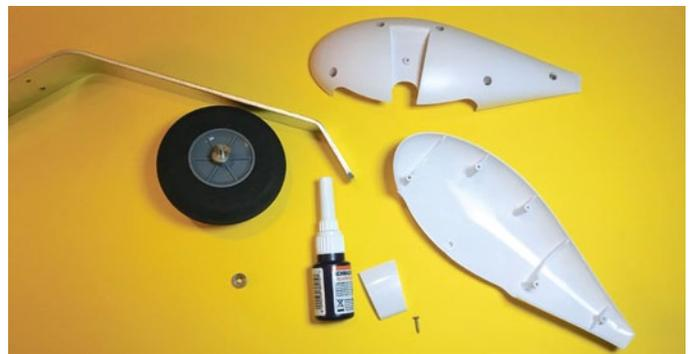
Die Radverkleidungen bestehen aus Hart-Kunststoff und verfügen über passgenaue Nuten an der Schnittstelle zum Fahrwerksbügel. So können sie sich nicht verdrehen
