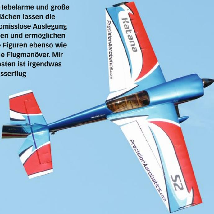
Was noch fehlte, das waren Servos, Akku und Spinner. Auch hier kamen die vom Hersteller empfohlenen Teile zum Einsatz, also vier Nexatec NXT-80DSM Servos mit Metallgetriebe, ein Präzisions-Carbonspinner mit 55 mm Durchmesser und dem 4s-LiPo Smart Devil 35C. Wir wollten wissen, ob sich hier eine perfekte Kombination fürs 3D-Fliegen ergibt.
