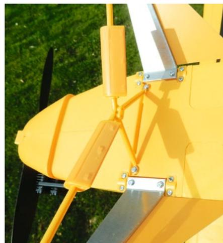
In den Dämpfern befinden sich sehr harte Federn, sodass das Fahrwerk wenig federt
