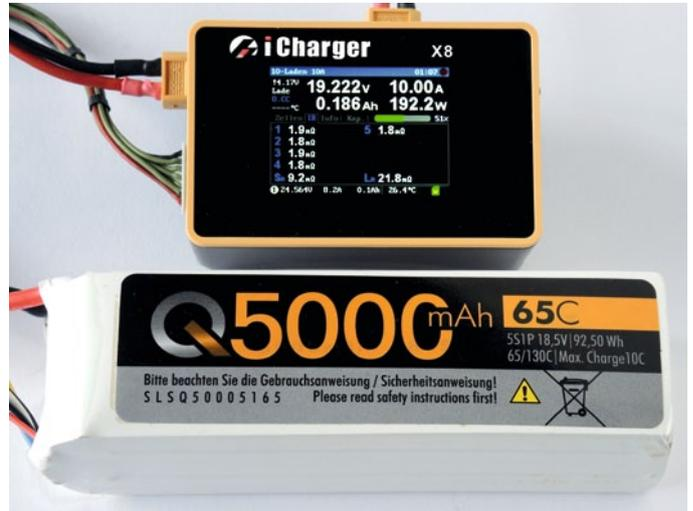
Praxistest beim X8 wurde mit einem 6s-LiPo mit 5.000 mAh Kapazität vom Typ Quantum durchgeführt
