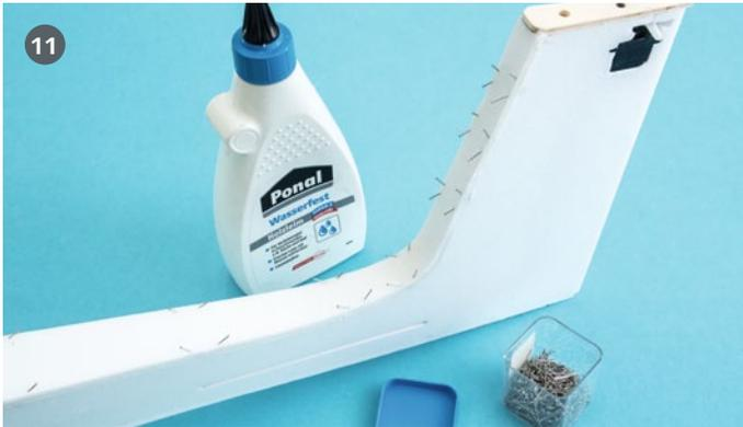
11 Der Rumpfrücken schließt gleichzeitig auch das Seitenleitwerk. Weil dort eine enge Biegung erforderlich ist, muss man das Depronmaterial beidseitig fein anschleifen, damit die spröde Oberflächenschicht kein Einreißen provoziert. Die gute alte Stecknadelmethode ist auch bei Depronbaugruppen ein gut geeignetes Mittel
