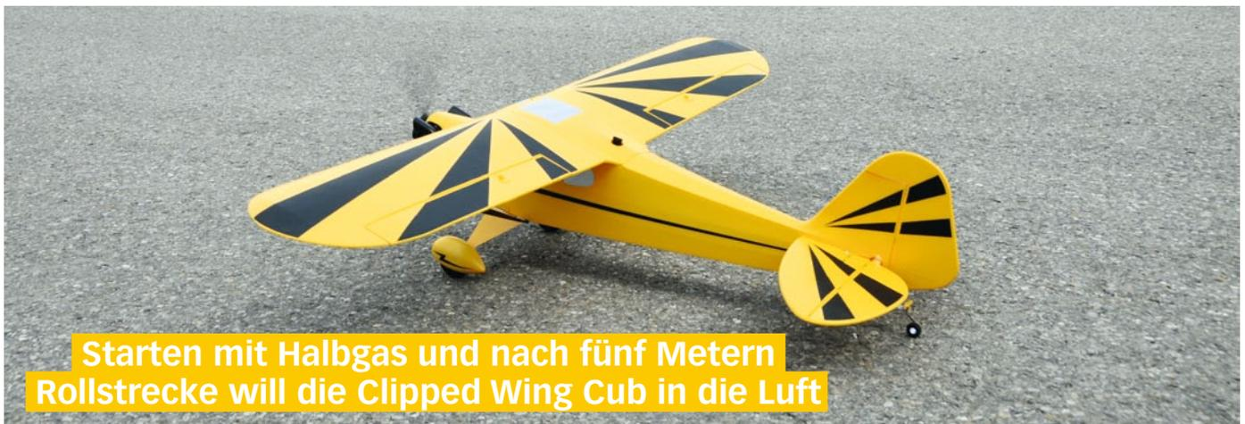
Starten mit Halbgas und nach fünf Metern Rollstrecke will die Clipped Wing Cub in die Luft
