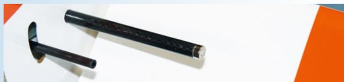
Auf dem Steckungsstab des Pendelleitwerks sitzt ein starker Magnet, das Gegenstück sitzt im Steckungsrohr
