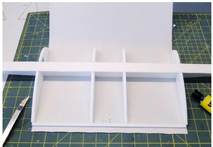
Der Flügel entstand exakt nach Vorgabe des vergrößerten Modellbaubogens. Die einteilige Beplankung des Mittelstücks geht komplett um die Flügel Nase herum
