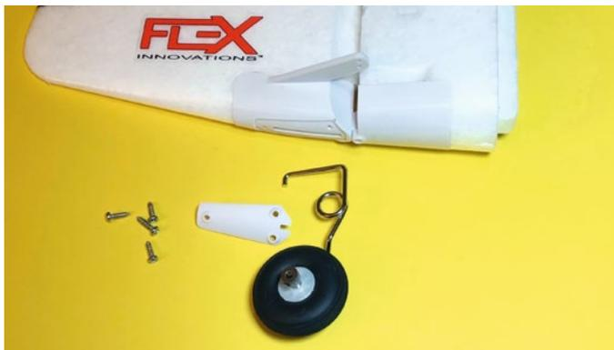
Das gefederte Heckrad wird direkt in das Seitenruderblatt montiert (anhand von ABS Formteilen) und ist dadurch lenkbar
