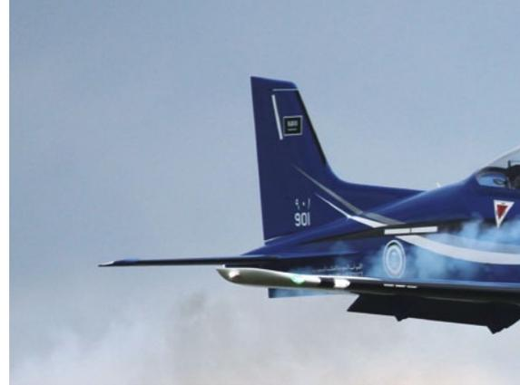
Der Full-Scale-Militärtrainer Pilatus PC-21 aus dem Hause Tomahawk wurde von Sven Felbinger hervorragend präsentiert. Das Scale-Modell ist in den Farben der Royal Saudi Airforce lackiert und wird von einer Propellerturbine JetCat SPT-10RX angetrieben. Spannweite 2.680 mm und Gewicht 23,5 kg
