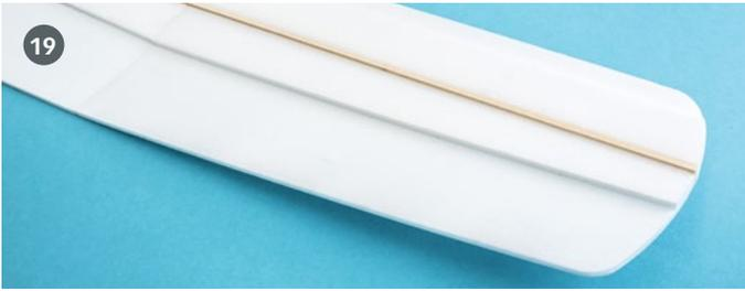
19 Noch ist alles komplett unverschiffen und wurde lediglich aus passgenau ausgetrennten Einzelteilen zusammengefügt. Man erkennt bereits das Kfm3-Profil, welches auf der Oberseite zwei Stufen besitzt. Eine 3-mm-Kante bildet der Holm, und weiter hinten gibt es eine 6-mm-Stufe aus Depron
