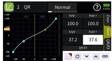
Die Konfiguration eines Mischers gelingt mit Hilfe der farbigen Grafik schnell und sicher
