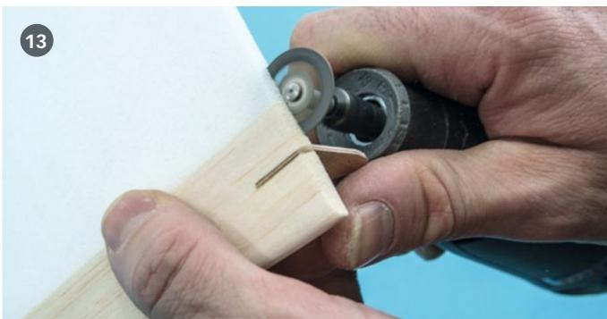
13 Eine Möglichkeit die Vlies-Scharniere in Holz einzubringen, ist eine möglichst dünne Metall-Trennscheibe. Auf diese Weise spleißt das Holz nicht auf
