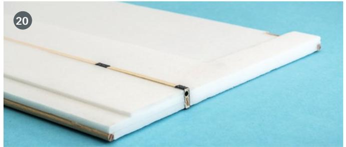
20 Die komplette Flügel-Nasenleiste wird mit einem 6-mm-Buchenholzstab ergänzt. Das ist nicht nur robust, sondern gibt auch die Rundung vor, wodurch der Profilschliff deutlich vereinfacht wird
