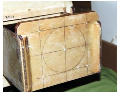
Das Fertigteil zur Motormontage ist bereits herstellerseitig mit Gewebe überzogen, Sturz und Seitenzug ausgestattet wird für den DA 85 mit Heckvergaser vorbereitet
