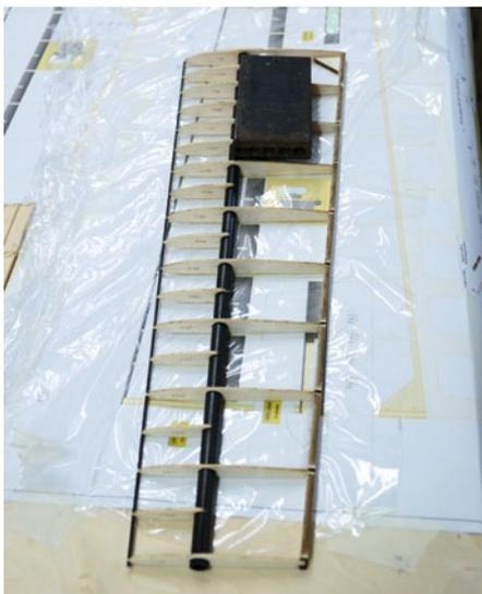
Eines der beiden Flächenaußenteile ist fast fertig
