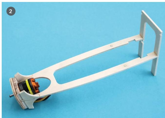
Aus einer Handvoll 4-mm-Pappelsperholz-Bauteilen setzt sich ein Innengerüst zusammen, welches im vorderen Bereich den Motorsturz sowie den Motorseitenzug fix und fertig einstellt. Um später die Kabinenhaube festzuhalten, setzen wir weiter hinten zwei zylindrische Rundmagnete (4 x 4 mm) ein
