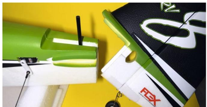
Das Seitenleitwerk ist noch nicht mit dem Rumpf verbunden, sondern einzukleben. Zur exakten Positionierung dienen formschlüssige Konturen. Im Inneren wird zur Versteifung ein CFK-Rohr mit eingeklebt
