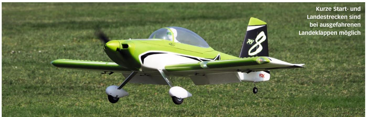
Kurze Start- und Landestrecken sind bei ausgefahrenen Landeklappen möglich
