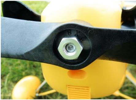
**Kann passieren:** Die Welle des Propellermitnehmers ist zu stark angezogen und dann abgerissen, fliegen geht trotzdem
