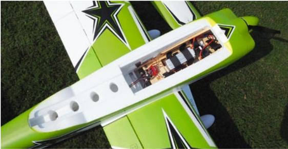
Der große Zugang erleichtert das Einsetzen des Flug-Akkus. Vorne ist ein 6s-LiPo zu sehen. Vor der Flächensteckung befindet sich das Aura 8, in das zwei Spektrum-Satelliten eingesteckt sind
