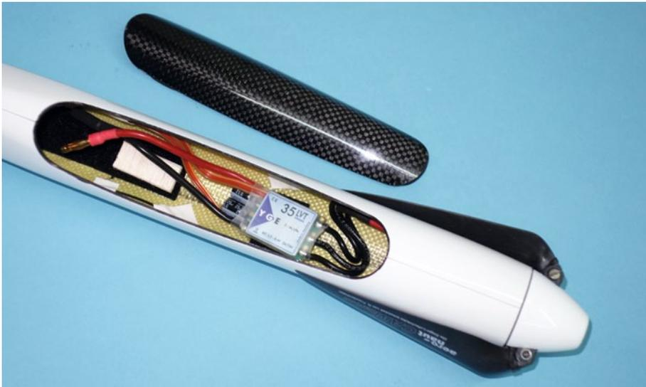
**Im Sprite von mahmoudi modellsport kommt der YGE35LVT zum Einsatz. Er sitzt am Rumpfboden festgeklebt und gut zugänglich direkt hinter dem Motor**
