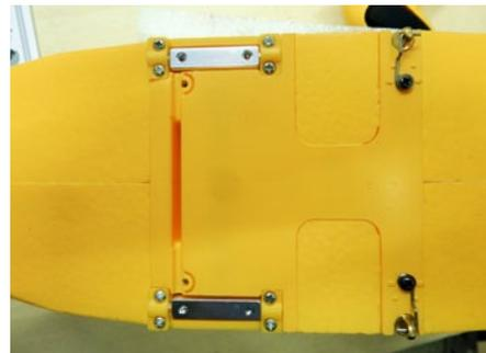
Die Fahrwerksbefestigung ist beweglich gelagert. Hier gut zu sehen sind auch die Befestigungsclips für die Flügelstreben
