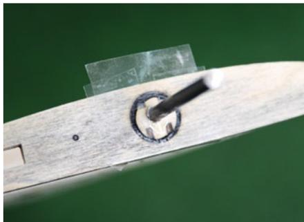
Der eine Teil der Steckung ist mit Kleber im CFK-Rohr eingesetzt und mit einem Tesastreifen abgesperrt, um das Ganze im nächsten Schritt exakt zu befestigen
