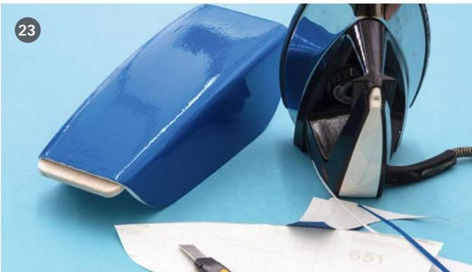
23 Nach dem Runden der Rumpfkanten sind wir auch schon so weit, dass es an die Verschönerungen gehen kann. Der Dekorvorschlag ist im Bauplan enthalten, was wir mit selbstklebender Werbebeschriftungsfolie „Oracal“ und einem kalt eingestellten Bügeleisen umsetzen können. Wer lieber pinselt, kann sich mit wasserbasierenden (lösemittelfreien) Lacken austoben
