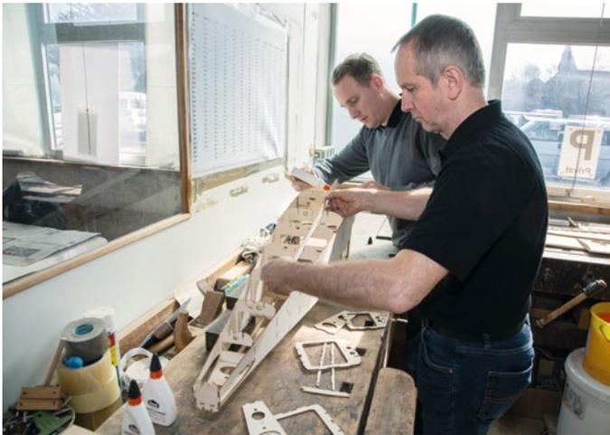
Nach alter Väter Sitte wird ein Prototyp aufgebaut. Dabei wird die Passgenauigkeit der Bauteile geprüft
