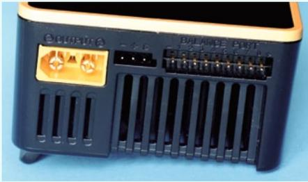
Die linke Gehäusesseite mit den Anschlüssen für Akku, Servo und Balancer
