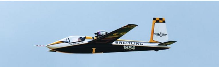
CARF Models präsentierte den brandneuen Kunstflugsegler SZD Kobus-3 im Maßstab 1:3,7. Das komplett aus GFK/CFK hergestellte Modell wurde zusammen mit Ceflix entwickelt, die auch die passende Ausfahrmechanik für das Triebwerk liefern. Die Spannweite liegt bei 4.350 mm und das Gewicht bei 17 bis 18 kg. Geeignet für Turbinen mit 80 bis 120N oder 120er-Impeller
