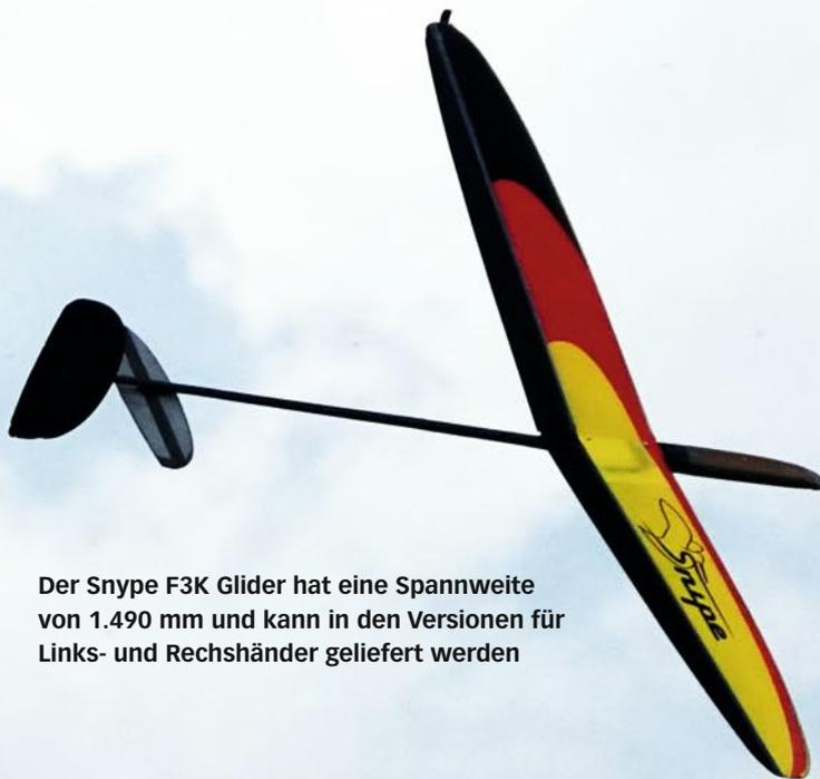
Der Snype F3K Glider hat eine Spannweite von 1.490 mm und kann in den Versionen für Links- und Rechshänder geliefert werden
