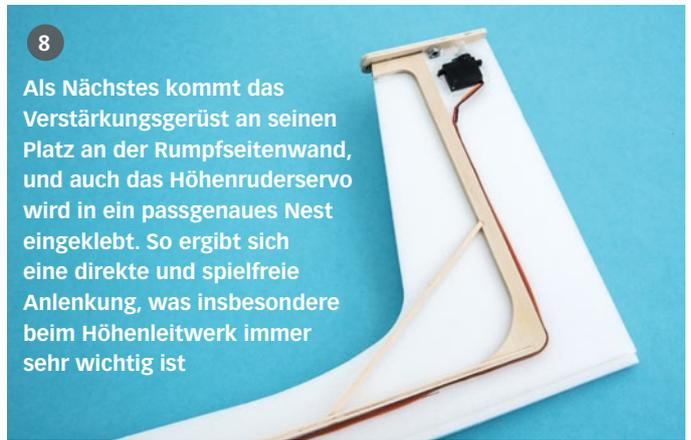
Als Nächstes kommt das Verstärkungsgerüst an seinen Platz an der Rumpfsseitenwand, und auch das Höhenruderservo wird in ein passgenaues Nest eingeklebt. So ergibt sich eine direkte und spielfreie Anlenkung, was insbesondere beim Höhenleitwerk immer sehr wichtig ist
