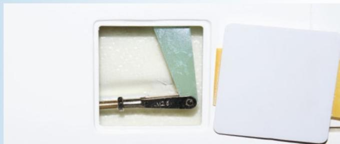
Der Hebel für das Pendelleitwerk ist richtig montiert und angelenkt
