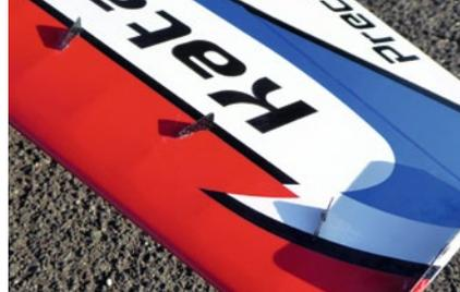
Die Vortexgeneratoren verwirbeln die Luftströmung und verzögern so den Strömungsabriss. Das führt zu einem sehr guten Flugverhalten bei hohen Anstellwinkeln
