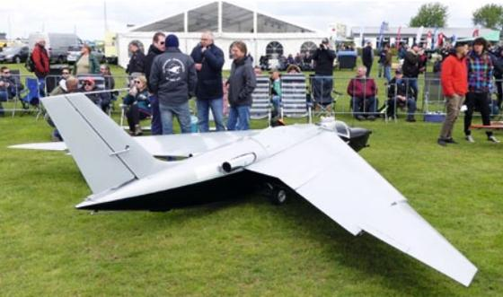
Für seine neue und 65 kg schwere Short SB.4 Sherpa hatte Erik von den Hoogen aus Holland erst kurz zuvor die Verkehrszulassung erhalten. Das Besondere an der Konstruktion dieses englischen Bombers ist, dass die für Höhen- und Quersteuerung zuständigen Flächen an die Flügelenden verlegt sind. Sie nehmen rund 20% der Gesamtfläche ein und werden quasi wie Tailerons um die Querachse verdreht
