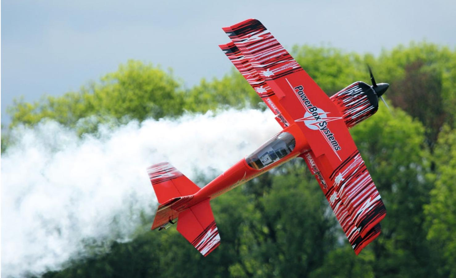
Im 3W-Slot flog Luca Baumann das Kunstflugmodell Ultimate 300 beeindruckend vor. Der Voll-GFK-Doppeldecker ist mit einem Vierzylinder 3W-140ib4 CS ausgerüstet, der samtweich läuft und einen sehr angenehmen Sound liefert. Der 17 kg leichte Flugapparat hat eine Spannweite von 2.400 mm und eine Länge von 2.600 mm
