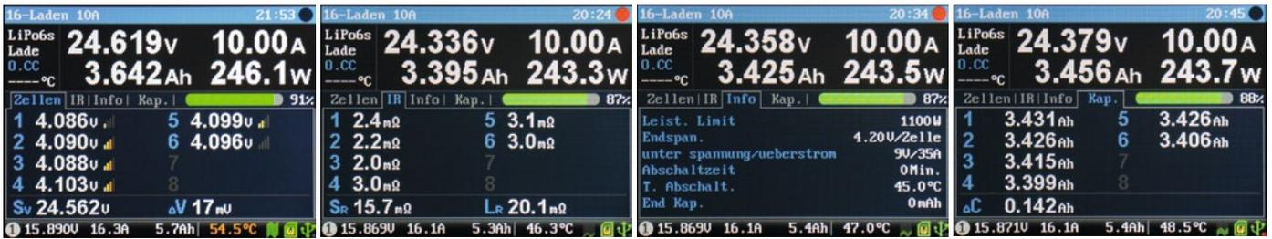
Beim Laden von LiPo-Akkus werden alle relevanten Daten auf vier Displayfenster Cells, IR, Info und Kap angezeigt
