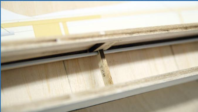
Vorgedacht und mitgemacht: Zur Führung der Bowdenzughüllen dienen spezielle Querstreben
