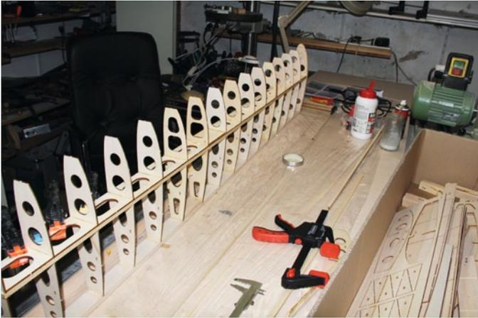
Im nächsten Schritt; Verstärkung des Sperrholzholms durch Kieferleisten oben und unten
