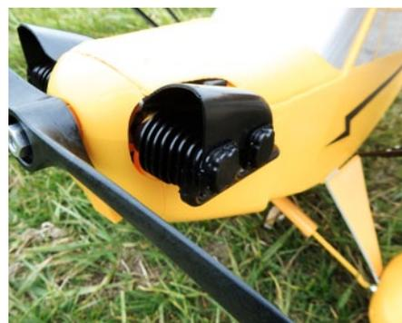
Die Motoratrappe ist eine Schau, sie dient gleichzeitig als Griff zum Öffnen des Akkuraums
