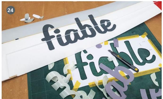
24 Für den Schriftzug legen wir den Bauplan Ausdruck auf die Klebefolie und fixieren alles mit Klebeband auf einer Schneidunterlage. Mit einem scharfen Cutter (frische Klinge!) schneiden wir alles in Ruhe aus und können daraufhin die Einzelteile an die im Plan angegebenen Stellen setzen
