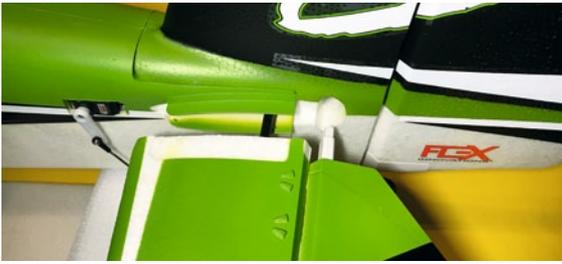
Zur formschlüssigen und torsionssteifen Verbindung von linkem und rechtem Ruderblatt hat der Hersteller Hart-Kunststoffteile verwendet. Als Steckung dient ein CFK-Rohr
