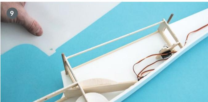
Das vordere Rumpfskelett bekommt nach hinten noch eine Erweiterung, damit die Flügelauflage verstärkt wird. Ein hinterer Spant nimmt den zweiten Gummiring-Aufnahmedübel auf, und dort befindet sich auch ein kleiner Spant zum Einsetzen des Seitenruderservos. Jetzt kann die linke Rumpfsseitenwand mit Weißleim aufgesetzt werden. Dabei gut peilen, damit wir keine Banane bauen
