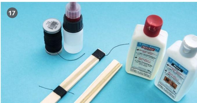
17 Die angeschliffenen Hülsen können wir mit Epoxi im Holm einkleben. Sicherheitshalber wickeln wir an den Stellen, wo der Holm aufsprengen könnte, noch etwas Nähgarn herum und tränken die Wicklungen mit dünnflüssigem Sekundenkleber.
