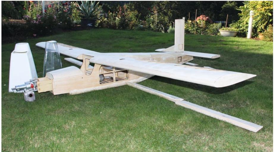
Der Rohbau steht und der DA 85 ist montiert
