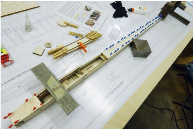
Nachdem die Spanten eingeklebt sind, gibt der Rumpfrücken Stabilität
