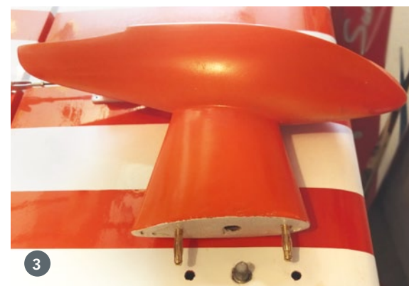
1. Um gut an den 6s-LiPo zu kommen, wird die Haube ausgeschnitten und verkastet. Der „ventilierte“ Akkuschaft steht schon bereit zum Einbauen. 2. Ein guter Freund lackierte mir Modell sowie Stützwimmer und montierte gleich noch die von einem Schneidplotter ausgeschnittenen Wappen, Zahlen und Schriftzüge. 3. Die seitlich angebrachten Stützwimmer werden mittels 4-mm-Goldstecker-Buchsen befestigt. Später geht dennoch ein Stützwimmer verloren, sodass sie seitdem noch zusätzlich durch je eine Kunststoffschraube gesichert sind
