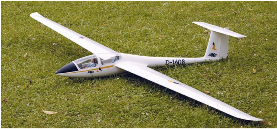
Abbildung 9: Die ASK-21 hat bei über 3.200 mm Spannweite eine Abflugmasse von nur knapp 2.800 g. Wenn man so möchte, ist sie ein riesiger Leichtwindsegler
