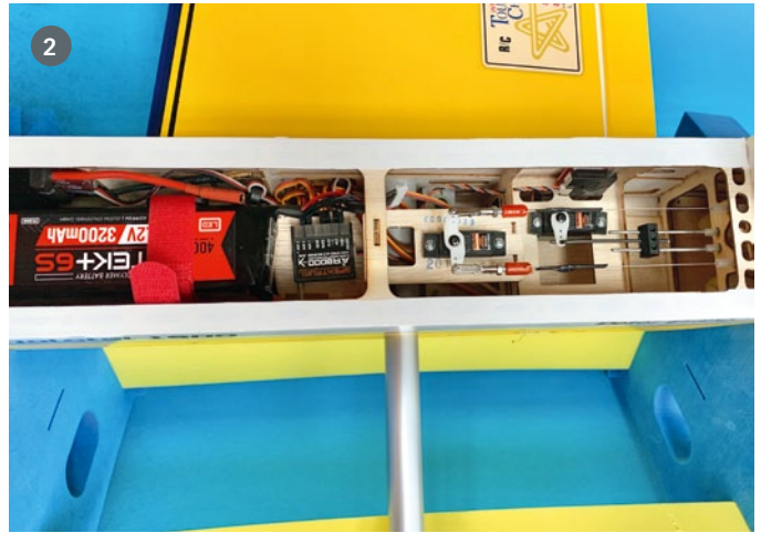
1. Linkes und rechtes Höhenruder werden über je ein Gestänge angelenkt, die Führungsrohre sind bereits herstellerseitig installiert. Die Anlenkung des Seitenruders erfolgt beidseitig über Seilitze. 2. Über die große abnehmbare Kabinenhaube ist alles gut zugänglich. Die beiden Stahldrähte zur Anlenkung der Höhenruder werden vor dem Servo gekoppelt
