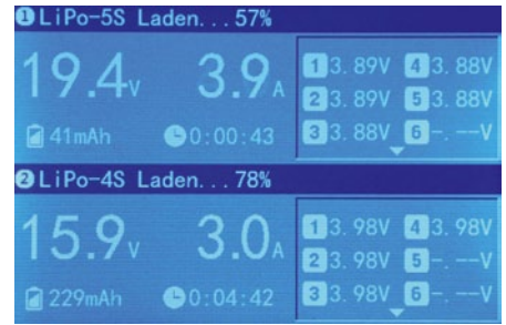
Während eines laufenden Vorgangs werden alle relevanten Daten visualisiert, zum Beispiel Einzelzellenspannungen
