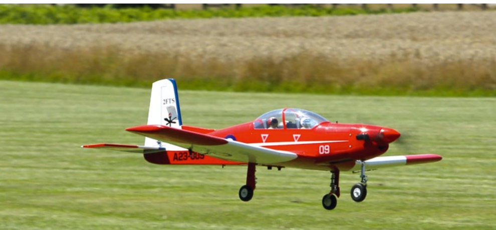
Das leicht gezogene Höhenruder kompensiert den abnehmenden Auftrieb durch die geringe Fahrt beim Landeanflug dieser PC-9 und verhindert so ein zu starkes Durchsacken des Modells
