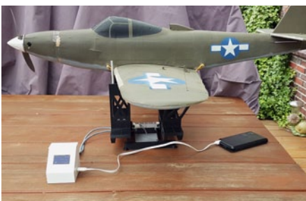
Schwerpunkt-Waage im Einsatz – endlich lassen sich exakte und reproduzierbare Einstellungen vornehmen
