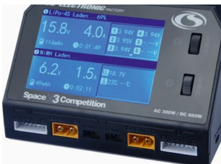
Sämtliche Akkuanschlüsse sind gut zugänglich im unteren Bereich der Frontseite platziert. Die Bedienung erfolgt über jeweils ein Drehrad mit Enter-Funktion, beide unabhängige Displays lassen sich gut ablesen
