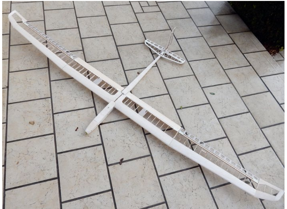
Der Rohbau ist eine Augenweide und macht schon jetzt Lust aufs Fliegen – vorher ist der FXj 2,5 noch zu bespannen
