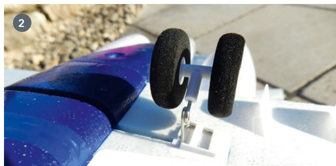
1. Das Bugrad ist angesteuert und kann bei Bedarf demontiert werden. 2. Die Zwillingssreifen des Fahrwerks sind eine Schau – natürlich lässt sich auch das Hauptfahrwerk demontieren
