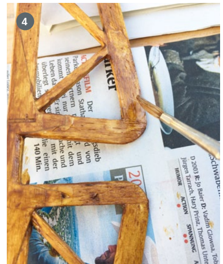
Alle Holzteile sind gründlich mit dem Klebergemisch einzustreichen
