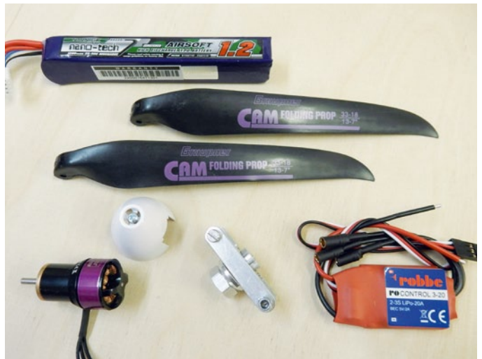
Das optionale Antriebsset bestehend aus einem Hacker-Motor mit Getriebe, schmalen Akku, Propeller und Regler ist hochwertig und absolut empfehlenswert
