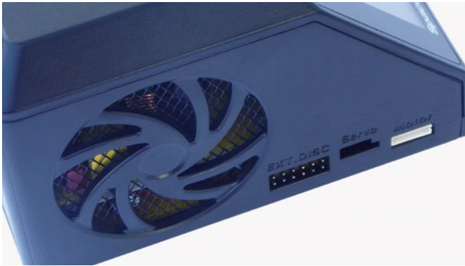
Im linken Seitenteil befinden sich neben dem Luftauslass die Ports für ein externes Entladegerät, einen Servo- und Motortester
