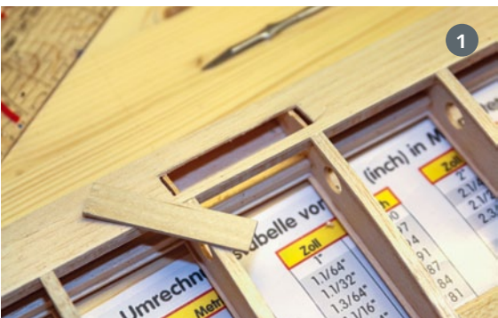
1. Die obere Beplankung wird an definierter Stelle ausgeschnitten, um dem Lagerblock für die Flächenstreben Platz zu schaffen. 2. Der Lagerblock der Flächenverstrebungen, ein weiterer sitzt mitten in der Fläche, ist eingepasst
