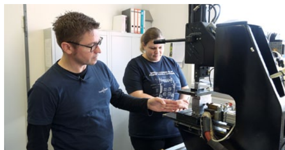
Richard Deutsch erklärt Funktion und Aufgabe der Hotmelt-Vergussmaschine, die beispielsweise Stecker mit Kabeln oder Bauteile hochfest versiegelt
