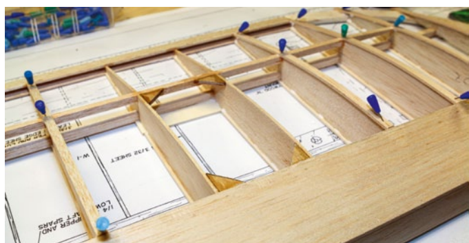
Sperrholzdreiecke dienen als Grundlage zum Verschrauben der Servowartungsklappe
