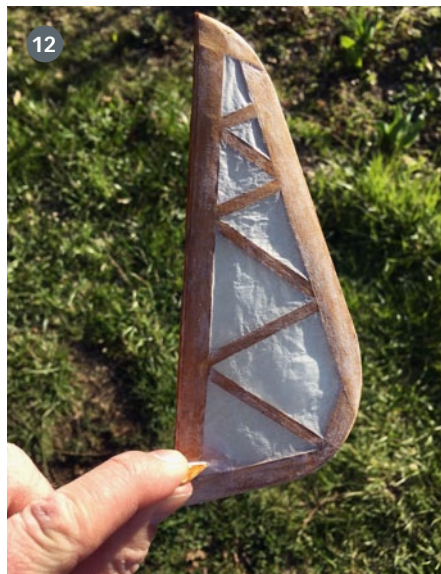
Nach dem Benetzen fällt das Papier etwas ein, spannt sich aber beim Trocknen wieder
