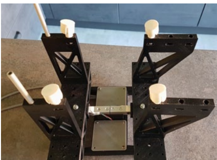
Ebenfalls neu dazugekommen ist eine Schwerpunkt-Waage aus Eigenbau- und Freeware-Elementen
