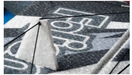
Jede Menge Streben halten den Flügel, aber auch alle anderen Modellteile gerade. Beim Bauen ist da viel Sorgfalt Pflicht
