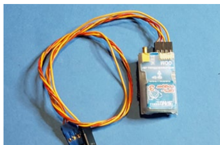
Drittes neues Helferlein ist der GPS Logger 3 von SM-Modellbau, der endlich Aufschluss über die Geschwindigkeit der Modelle gibt
