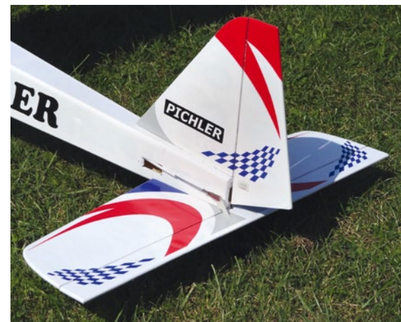
Zweckmodelle besitzen häufig einen langen Hebelarm und kommen daher mit geringen Heckruderausschlägen zurecht
