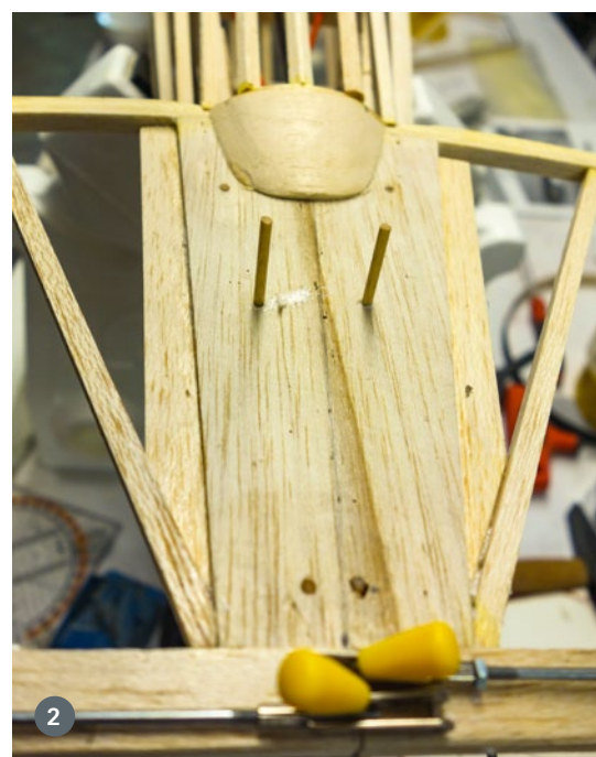
1. Um bei der Verspannung Stabilität reinzubringen, sind die Lager aus GFK-Plättchen geschnitten und formschlüssig eingearzt. Erkennbar ist hier auch eines der Kavanscharniere. 2. Nachdem das Höhenleitwerk exakt ausgerichtet ist, kann man es mit Weißleim auf den Rumpf kleben – Zahnstocher fixieren es und geben der Verklebung eine wesentlich höhere Stabilität bei Scherkräften
