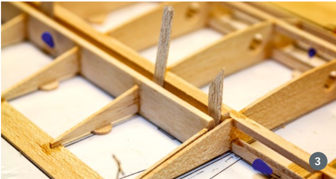
1. Die Holme werden auf dem Plan fixiert und die Rippen im rechten Winkel aufgesetzt sowie verklebt. 2. Aus vorgefertigten Balsateilen lassen sich die Randbögen laminieren – das ergibt einen starken und leichten Verbund. 3. Die Nasenleiste der Querruder wird mit Abfallholz auf Abstand gehalten, auch gilt es, die Rippen zu unterlegen. 4. Die Servos werden auf einem Brettchen eingepasst und mit Nutleisten am Platz gehalten sowie mit einer GFK-Zunge gesichert
