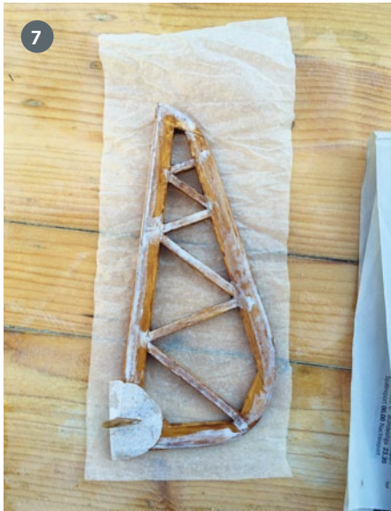
Zuschneiden und Anlegen des Bespannpapiers auf der einen Seite
