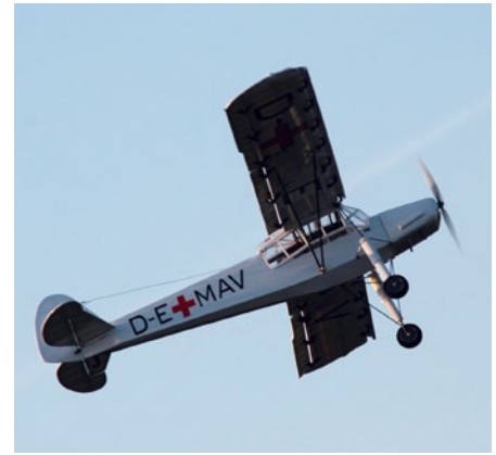
Abbildungen 5 und 6: Der kleine Fieseler Storch von PAF ist mit 1.200 mm Spannweite und nur knapp 800 g Abflugmasse extrem gutmütig und hat ein sehr ruhiges und vorbildgetreues Flugbild
