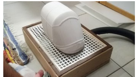
Für die Klarsichthaube war eine Urform als Tiefziehform zu erstellen
