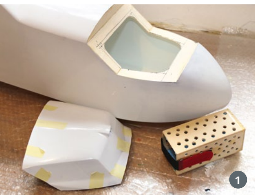
1. Um gut an den 6s-LiPo zu kommen, wird die Haube ausgeschnitten und verkastet. Der „ventilierte“ Akkuschaft steht schon bereit zum Einbauen. 2. Ein guter Freund lackierte mir Modell sowie Stützwimmer und montierte gleich noch die von einem Schneidplotter ausgeschnittenen Wappen, Zahlen und Schriftzüge. 3. Die seitlich angebrachten Stützwimmer werden mittels 4-mm-Goldstecker-Buchsen befestigt. Später geht dennoch ein Stützwimmer verloren, sodass sie seitdem noch zusätzlich durch je eine Kunststoffschraube gesichert sind
