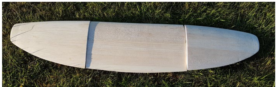
Sind alle Flügелеlemente beplankt, sind sie zusammenzufügen und abschließend auf konventionelle Weise zu bespannen
