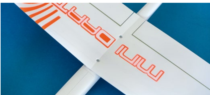
Zwei Schrauben sichern den leichten, stabilen und in Bezug auf die Oberflächenqualität hervorragend gefertigten Flügel
