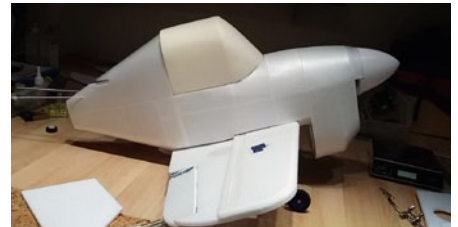
Zum Beplanken empfiehlt sich mal 1- und mal 3-mm-Depron. Der Flügel hat ein Kfm-Profil
