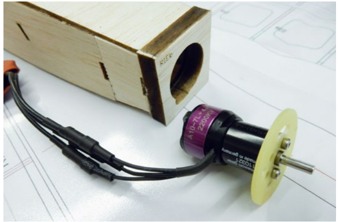
Will man einen Motor verwenden, muss der noch vor dem Schleifen in den Rumpf
