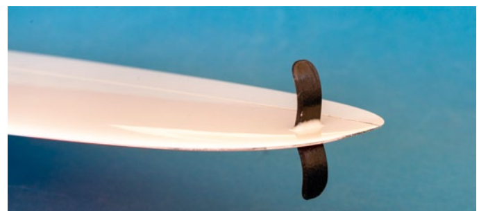
Ab Werk ist der geformte Wurfgriff, mit dem sich das Modell sehr gut fassen lässt, in der rechten Hälfte eingeklebt – es gibt keine Variante für links
