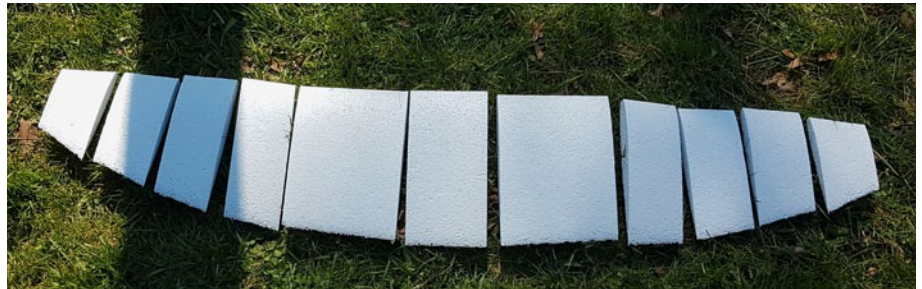
Nach der letzten Schneide-Aktion sind etliche Flügелеlemente der Hawker Tempest entstanden – hier exemplarisch nur für eine Fläche
