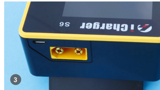
1) Im linken Seitenteil sind die Akkuanschlüsse, der Multifunktions-Port sowie der SD-Karten-Slot untergebracht. 2) Auf der rechten Seite befindet sich die Wippe zur Bedienung sowie ein kräftiger Lüfter. 3) Auf der Rückseite wird die Spannungsquelle über einen XT-90 Stecker angeschlossen, außerdem befindet sich dort ein Mini USB-Port
