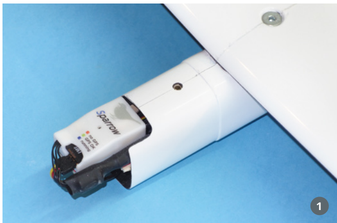
1) Hier ein Blick bei abgenommenem Rumpfvorderteil auf das GPS-Triangle-Telemetriesystem Sparrow von rc-electronics. Es vereint Vario sowie GPS und sendet einerseits autark auf 433 MHz, die wichtigsten Daten sind aber parallel auch auf dem Jeti-Rückkanal vorhanden. 2) Ein Blick unter die Haube im flugfertigen Zustand. Der Regler sitzt vorne rechts an der Rumpfsseitenwand, der Antriebsakku wird etwas nach hinten geschoben und in seiner Position fixiert. Vorne bleibt dann noch ausreichend Platz, um die Kabel zu stecken
