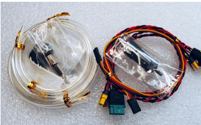
Frische Schläuche gehören bei einem Turbinen-Umbau unbedingt ins Modell. Im Fall der G4-Turbine aber auch neue Kabel mit passenden Anschlüssen
