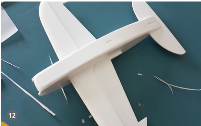
10.) Uhu Por hat sich zum Befestigen von Rumpfdeckel (durchgängiges Bauteil) und hinterem Rumpfboden bewährt 11.) Erneut sorgt die Schmirgelpapier-bewehrte Schwammrolle für runde Kanten – jetzt am Rumpf 12.) In die vorbereiteten Schlitze – kann man auch weglassen – ist das Seitenleitwerk mit Kanzel zu stecken 13.) Bei diesen Modellen hat sich das Uhu Por-Scharnier bewährt. Es ist schnell gemacht und simpel
