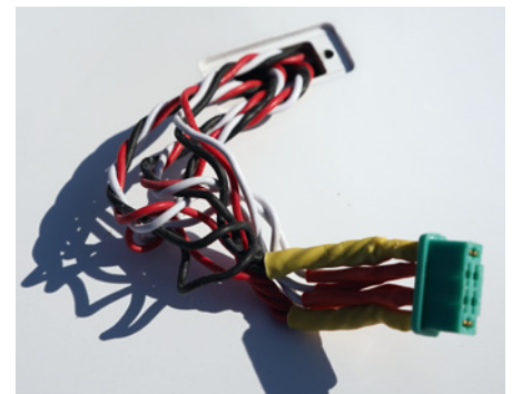
In der PNP-Version ist der Kabelbaum ebenfalls ab Werk fertiggestellt – bei PNP sind die Servos einsatzbereit
