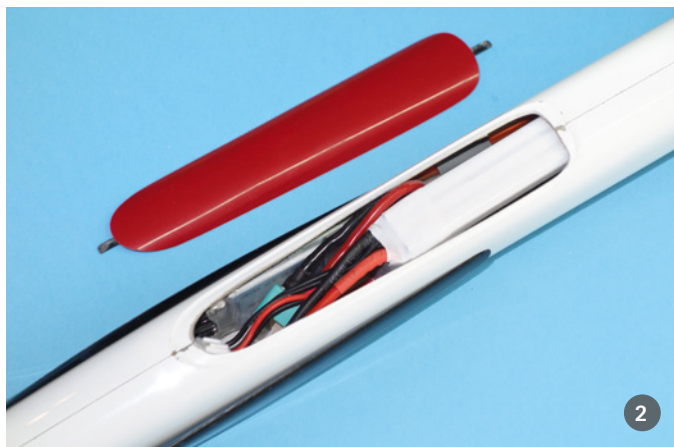
1) Hier ein Blick bei abgenommenem Rumpfvorderteil auf das GPS-Triangle-Telemetriesystem Sparrow von rc-electronics. Es vereint Vario sowie GPS und sendet einerseits autark auf 433 MHz, die wichtigsten Daten sind aber parallel auch auf dem Jeti-Rückkanal vorhanden. 2) Ein Blick unter die Haube im flugfertigen Zustand. Der Regler sitzt vorne rechts an der Rumpfsseitenwand, der Antriebsakku wird etwas nach hinten geschoben und in seiner Position fixiert. Vorne bleibt dann noch ausreichend Platz, um die Kabel zu stecken
