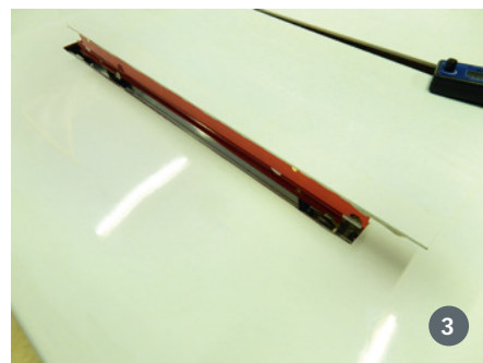
1) Spielfreie Anlenkung auch bei den Querrudern, die passgenau im fertigen Rahmen montiert sind. 2) Störklappen können oben und unten montiert werden, beides ist vorbereitet. 3) Die Klappe ist sehr schnell eingebaut und mit der mitgelieferten Abdeckung versehen
