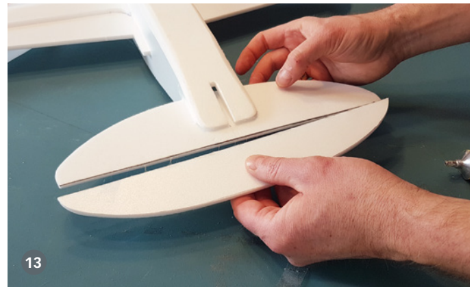
10.) Uhu Por hat sich zum Befestigen von Rumpfdeckel (durchgängiges Bauteil) und hinterem Rumpfboden bewährt 11.) Erneut sorgt die Schmirgelpapier-bewehrte Schwammrolle für runde Kanten – jetzt am Rumpf 12.) In die vorbereiteten Schlitze – kann man auch weglassen – ist das Seitenleitwerk mit Kanzel zu stecken 13.) Bei diesen Modellen hat sich das Uhu Por-Scharnier bewährt. Es ist schnell gemacht und simpel
