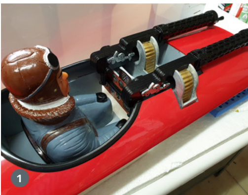
1) Hier das Cockpit in Serienausführung und die mitgelieferte Pilotenbüste, die mit ihren gut 350 g reichlich Übergewicht hat. Vor dem Cockpit sind die serienmäßigen, aus Holz gefertigten Maschinengewehre montiert, die aber recht gut detailliert sind. Die Rutschen der Patronenführung sind aus ABS. 2) Nun sitzt ein zünftig gekleideter Pilot der Firma 3Dforyou im Cockpit. Davor die beiden aus dem 3D-Drucker stammenden LMG 08/15-Maschinengewehre, die ebenfalls von 3Dforyou geliefert wurden. Leider sind beim Transport zum Platz die beiden Rutschen der Patronenführung der Maschinengewehre abgefallen und konnten nicht zum Fototermin montiert werden. 3) Links der Serienpilot, rechts der von 3Dforyou. Letztgenannter hat hier noch den Kopf vom „Roten Baron“. Beim genauen Hinsehen sind beim rechten Piloten die beiden installierten Servos zu erkennen, die auf Funkkommando den rechten Arm und den Kopf bewegen
