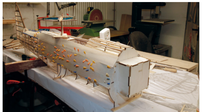
Eine kleine Fleißarbeit ist das Beplanken. Dafür gewinnt der Rumpf an Festigkeit, wie man sie sich wünscht
