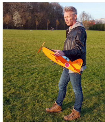
Zum Start das Modell von oben halten und lässig mit Halbgas aus der Hand werfen
