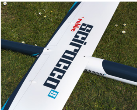
Der Flügel ist dreiteilig ausgeführt. Das Mittelstück geht nahtlos in den Rumpf über
