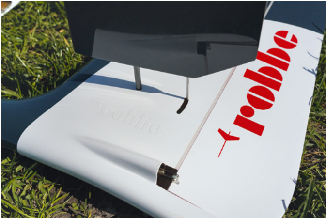
Die Haltekraft der CFK-Steckung ist so ausgelegt, dass nach dem Aufstecken keine weitere Befestigung nötig ist
