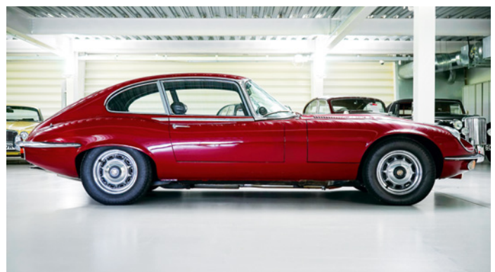
Abbildung 5: Der Jaguar E-Type hatte einen sehr geringen Widerstand wegen seines spitz zulaufenden Hecks.
