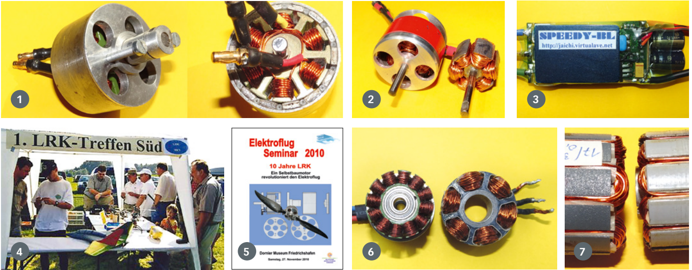
1) Mein erster LRK-Eigenbau mit Teilstator eines Bühler-Motors. Komponenten neu zu verwenden, war Standard. 2) Aus einer Graupner-Wasserpumpe ließen sich Teile nutzen, um einen Mini-LRK in Eigenregie zu erstellen. 3) Speedy-BL-Controller für vielpolige Außenläufer von Jo Aichinger. 4) Der erste LRK-Stand während des Flugtags der MFG Kressbronn, Bodensee im Sommer 2001. 5) Flyer zum Elektroflugseminar „10 Jahre LRK“ im Dornier Museum Friedrichshafen im November 2010. 6) Einzelzahnwicklung (rechts) und Verteilung der Wicklungen auf zwei Zähne (links). 7) Die verteilten Windungen ermöglichen schlankere Wickelköpfe
