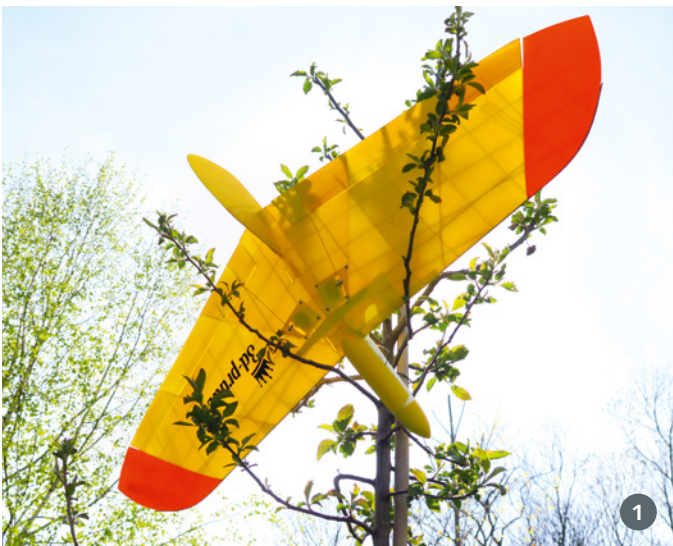
1) 3D-Modelle sind robust und schön zugleich, wie der Blick auf die Innenstruktur des LouLou zeigt. 2) LouLou ist gegenwärtig wohl der einzige discus-launch-fähige Segler aus dem 3D-Drucker, den man kaufen kann
