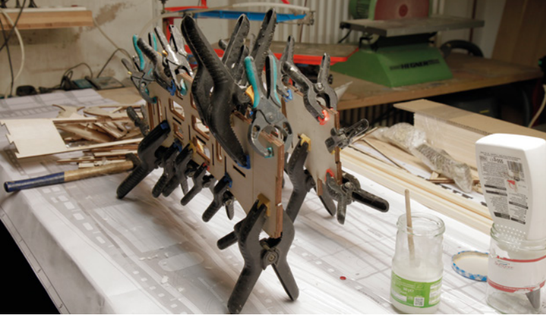
Los geht es mit dem Aufdoppeln der Seitenteile, die später Lasten zu tragen haben
