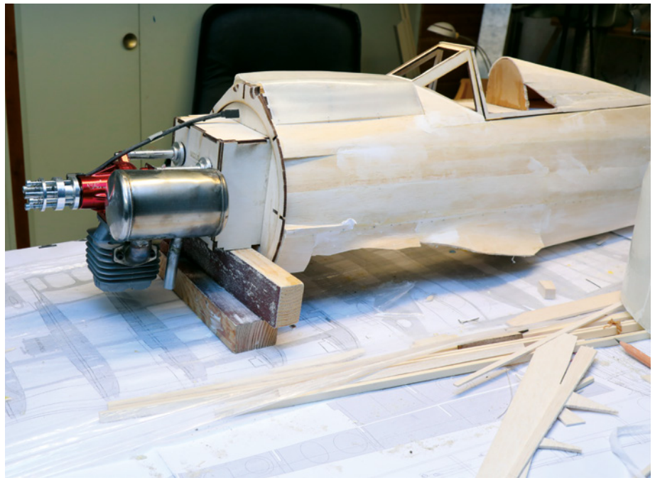
Der DLA 55 ist hängend eingebaut und der Topfdämpfer unmittelbar daneben, also unter der Haube platziert
