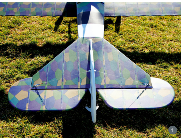
1) Die „vernähte“ Stoffbespannung und die Wellenform der Flügel-Endleisten lassen sich auf diesem Bild gut erkennen. 2) Der Unterschied zur hochglänzenden, konturlosen, aber sauber im Werk aufgetragenen Folie ist im direkten Vergleich besonders deutlich
