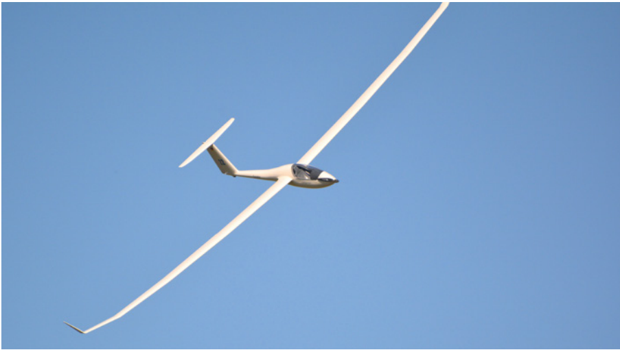
Schlanke Silhouette, kurzer Rumpf, hohe Streckung und Mehrfach-V-Form inklusive Winglets – der Ventus ist ein Hingucker
