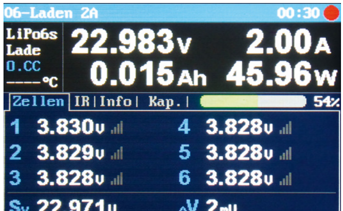
Während des Ladevorgangs lassen sich zahlreiche Parameter abfragen, zum Beispiel die Spannungslagen der einzelnen Zellen
