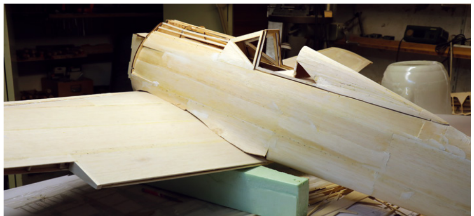
Anpassen des Flächen-Rumpf-Übergangs. Auch der Rumpf ist weiter zu schleifen und spachteln. Später folgt ein Überzug mit GFK-Matte
