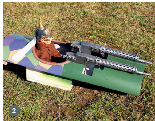
1) Hier das Cockpit in Serienausführung und die mitgelieferte Pilotenbüste, die mit ihren gut 350 g reichlich Übergewicht hat. Vor dem Cockpit sind die serienmäßigen, aus Holz gefertigten Maschinengewehre montiert, die aber recht gut detailliert sind. Die Rutschen der Patronenführung sind aus ABS. 2) Nun sitzt ein zünftig gekleideter Pilot der Firma 3Dforyou im Cockpit. Davor die beiden aus dem 3D-Drucker stammenden LMG 08/15-Maschinengewehre, die ebenfalls von 3Dforyou geliefert wurden. Leider sind beim Transport zum Platz die beiden Rutschen der Patronenführung der Maschinengewehre abgefallen und konnten nicht zum Fototermin montiert werden. 3) Links der Serienpilot, rechts der von 3Dforyou. Letztgenannter hat hier noch den Kopf vom „Roten Baron“. Beim genauen Hinsehen sind beim rechten Piloten die beiden installierten Servos zu erkennen, die auf Funkkommando den rechten Arm und den Kopf bewegen
