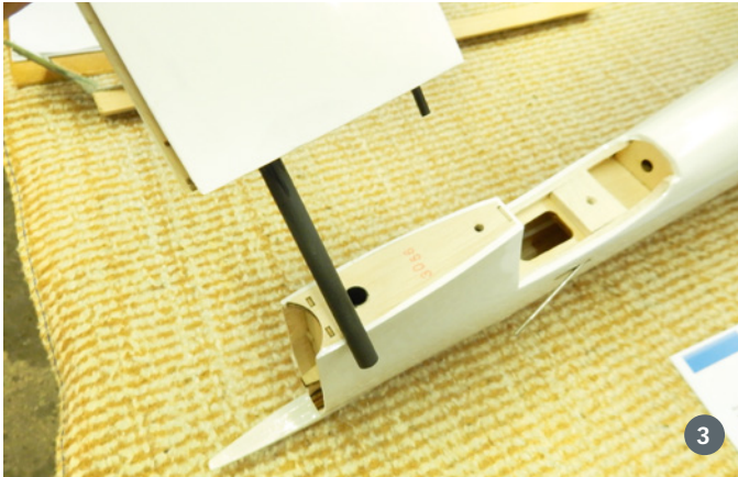
1) Die Anlenkung des Höhenruders erfolgt über eine Schubstange mit zwei Drähten am Ende. 2) Passt man das Schritt für Schritt an, ergibt sich eine absolut identische Anlenkung. 3) Die Dämpfungsfläche des Seitenleitwerks wird über einen Kohlestab stabil mit dem Rumpf verbunden und verklebt. 4) Steuerdrähte sorgen für eine spielfreie Anlenkung des Seitenruders
