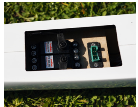
In den Multiplex-Stecker braucht nur noch das Gegenstück vom Kabelbaum aus der Fläche gesteckt werden
