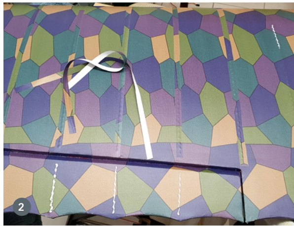
1) Die Wahl des manntragenden Vorbilds fiel auf die Fokker D-VII des schwedischen Piloten Mikael Carlson. Die Rauten-Tarnung ist von Hand kaum zu lackieren, darum kam hier fertig bedrucktes Oratex-Gewebe zum Zuge. 2) Für die Anfertigung der Nahtimitate mittels Weißleim wurden Maskierfolien geschnitten, die nach dem Aufbringen des Leims wieder abgezogen werden. Nach der Trocknung kommen noch die Nahtbänder drüber. 3) Die Nahtbänder sind bei der Fokker D-VII gerade geschnitten, also nicht als Zackenband ausgeführt, was das Zuschneiden leichter macht
