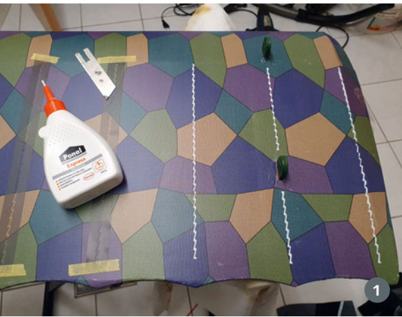
1) Die Wahl des manntragenden Vorbilds fiel auf die Fokker D-VII des schwedischen Piloten Mikael Carlson. Die Rauten-Tarnung ist von Hand kaum zu lackieren, darum kam hier fertig bedrucktes Oratex-Gewebe zum Zuge. 2) Für die Anfertigung der Nahtimitate mittels Weißleim wurden Maskierfolien geschnitten, die nach dem Aufbringen des Leims wieder abgezogen werden. Nach der Trocknung kommen noch die Nahtbänder drüber. 3) Die Nahtbänder sind bei der Fokker D-VII gerade geschnitten, also nicht als Zackenband ausgeführt, was das Zuschneiden leichter macht
