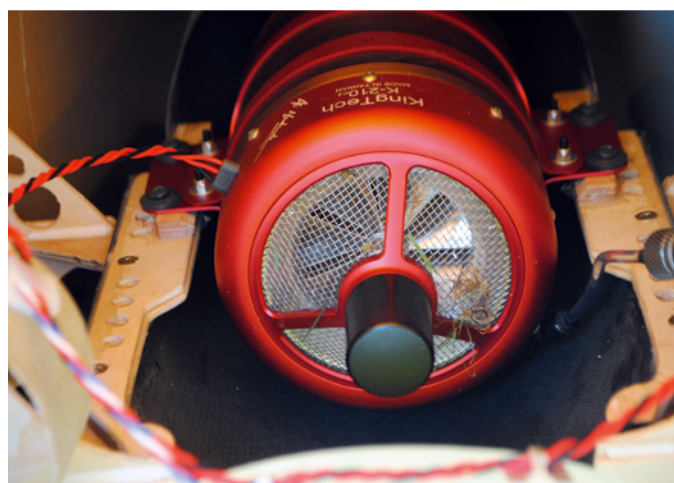
Wie wichtig ein Einlaufsieb ist, lässt sich hier erkennen. Die Turbine ist relativ weit hinten in der Hawk eingesetzt
