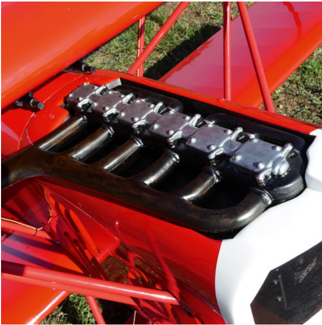
Serienmäßig wurde eine relativ einfache, glänzend schwarz lackierte Zylinderbank-Attrappe mitgeliefert. Die hier abgebildete hatte der Autor bereits farblich behandelt
