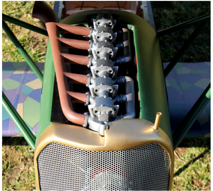
Das Bild der modifizierten Maschine zeigt die im 3D-Druck entstandene Motor-Version, die allerdings auch noch optisch verfeinert wird
