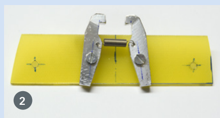
1) Das selbst erstellte Aludrehteil gehört zur Haltevorrichtung der Motorglocke im zurückgezogenen Zustand. 2) Diese zwei Haken umfassen das Aludrehteil und halten somit die Glocke in der hinteren Stellung fest. 3) So sieht das Ganze in der Praxis aus: Motorglocke hinten, die beiden Aluteile greifen. 4) Ist die Motorglocke nach vorne für den E-Antrieb geschoben, bleiben die Aluteile wirkungslos
