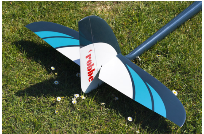
Das Seitenruder ist ab Werk anscharniert und die Anlenkung umgesetzt
