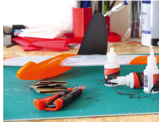
Hier entsteht gerade ein Flightboard light. Sekundenkleber und Aktivator sind hierbei gute Helfer
