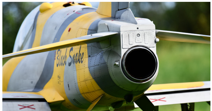
Beim Turbinen-Auslass muss beim Umrüsten auf eine andere Turbine selten etwas verändert werden, aber ob die Distanz im Inneren noch passt, also zwischen Turbine und Schubrohr, das sollte man prüfen
