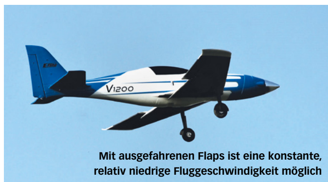
Die dunkle Unterseite unterstützt die Fluglageerkennung
