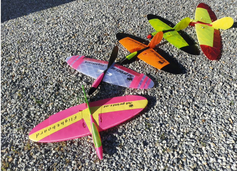
Ein Modell, aber verschiedene Designs – so viel Individualität ermöglicht der 3D-Druck, wie die Flightboard-Familie zeigt
