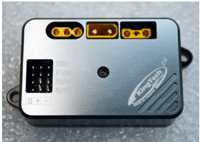
Im Modell verbaut wird das Telemetrie-Modul, das hier bereits mit XT-Stecker ausgestattet ist
