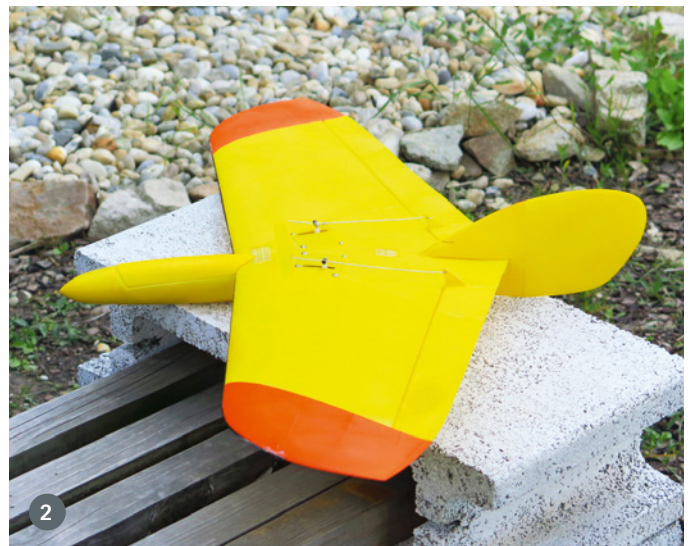
1) 3D-Modelle sind robust und schön zugleich, wie der Blick auf die Innenstruktur des LouLou zeigt. 2) LouLou ist gegenwärtig wohl der einzige discus-launch-fähige Segler aus dem 3D-Drucker, den man kaufen kann
