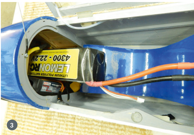
1) Diese massive Platte fixiert die Flügel im Rumpfinnenen. 2) Die GFK-Gurte sind mit angebauten Flügeln zu verkleben. Kein ganz einfacher Bauabschnitt. 3) Weder die herstellerseitig vorgesehene Platzierung des Akkus noch diese funktionierte. 4) Also kam die Kupplung wieder raus und anstelle ihrer eine Akkuhalterung rein. Jetzt passt der Akku unter den Pilotensitz
