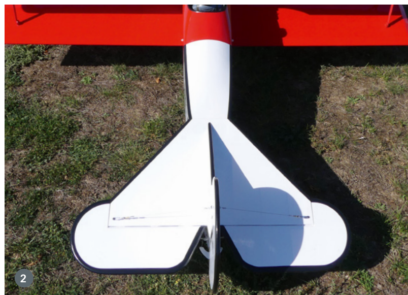
1) Die „vernähte“ Stoffbespannung und die Wellenform der Flügel-Endleisten lassen sich auf diesem Bild gut erkennen. 2) Der Unterschied zur hochglänzenden, konturlosen, aber sauber im Werk aufgetragenen Folie ist im direkten Vergleich besonders deutlich
