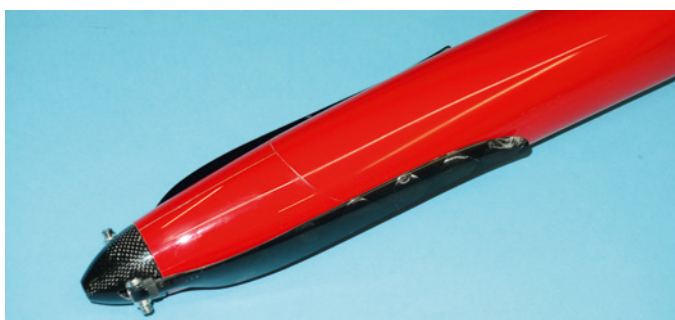
Hier sind Spinner und Luftschraube provisorisch vormontiert, die Spinnerform passt sehr gut zur Rumpfspitze
