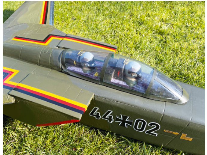
Das stilisierte Cockpit wurde mittels Vivak-Kunststoff im Backofen tiefgezogen und mit Hilfe von Elektronikbauteilen (Draht, Widerstände, Klickschalter, Relais) dekoriert
