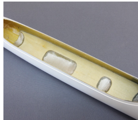
Ein großzügiges RC-Brett verstärkt den Rumpf im Bereich des Haubenausschnitts, eingedicktes Harz und Glasfasergewebe sorgen für eine optimale Verbindung
