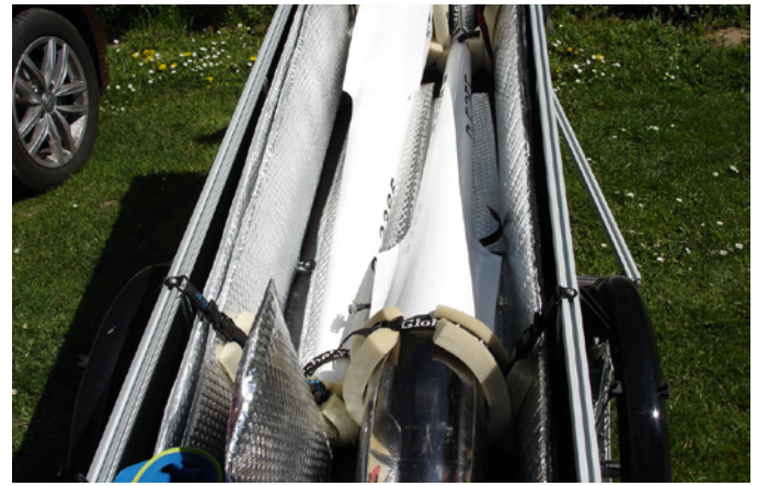
Gurte sichern die Ladung und Schaumeinlagen verhindern Kratzer. Flügel lassen sich seitlich und Rumpfe mittig platzieren
