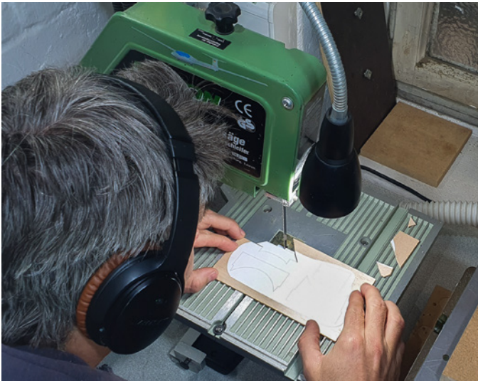
Früher war das so: Bauplan ausdrucken, aufs Holz aufkleben, dann mit der Bandsäge aussägen. Mit Übung und anschließendem Schleifen wurde das schon ordentlich
