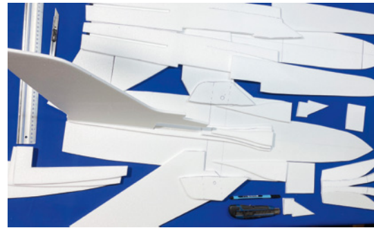
Bei allen doppelt vorhandenen Bauteilen, beispielsweise den Tragflächen oder Tailerons, muss auf absolute Passgenauigkeit geachtet werden
