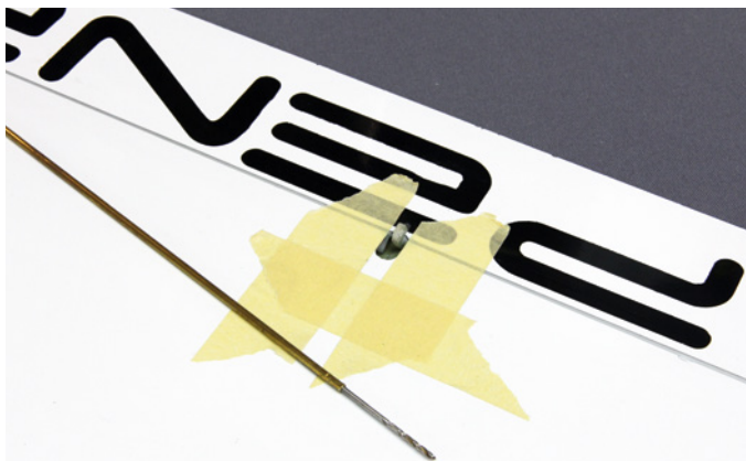
Da die GFK-Ruderhörner nur 1,5-mm-Bohrungen aufweisen, lassen sich die Gabelköpfe mit 1,6-mm-Pins sehr schwer und nur mit viel Reibung montieren. Abhilfe schafft ein per Messingrohr verlängerter 1,6-mm-Bohrer, mit dem die Ruderhörner vorsichtig aufgebohrt werden
