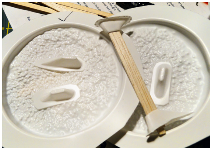
Für die äußeren Flügelstreben wurden die Verkleidungen selbst tiefgezogen. Die Formen sind aus Ureol-Formenbaumaterial gefertigt
