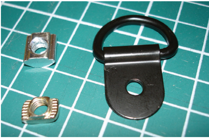
Nutensteine eignen sich ideal zum Verschrauben der Alu-Nutprofile und Befestigen von D-Ringen für die Ladungssicherung
