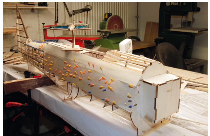
Beim Bau der FW-190 ist das Beplanken eine kleine Fleißarbeit. Zwar gewinnt der Rumpf an Festigkeit, aber auch an Gewicht
