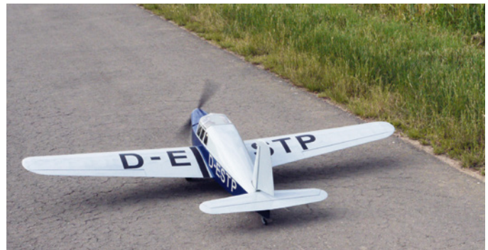
Abbildung 4: Die Siebel 202c von RBC liegt mit dem Maßstab von 1:5 eher an der unteren Grenze zum Großmodell, sie fliegt aber auch nur knapp 25% schneller als es originalgetreu wäre
