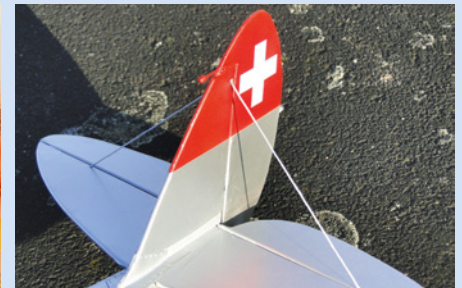
Und so sieht's fertig aus: Eine dünne Schicht seidenmatter Klarlack sorgt für einen einheitlichen Oberflächenglanz
