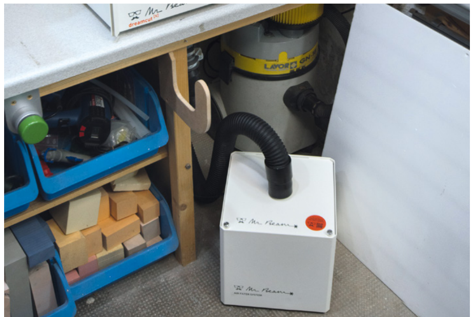
Unter der Werkbank findet neben dem Werkstattsauger die Aktivkohle-Filteranlage ihren Platz. Sie ist sowohl mit einem Abluftschlauch als auch elektrisch mit Mr Beam verbunden
