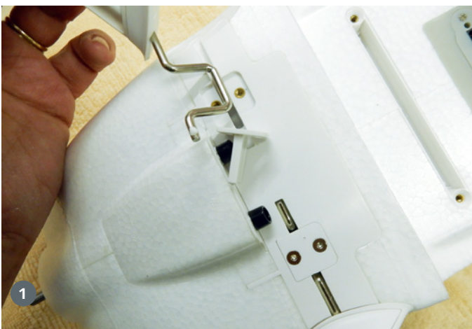
1) Die beiden sehr stabilen Fahrwerksbeine werden von einem Kunststoffträger aufgenommen, der die Fahrwerkskräfte großflächig in den Schaum des Rumpfs einleitet. 2) Alle Schraubverbindungen erfolgen mit metrischen M3-Inbusschrauben
