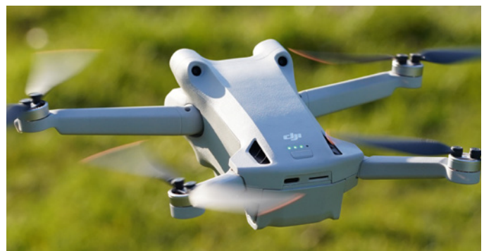
Nach hinten abtastende Sensoren sind hinter den vorderen platziert
