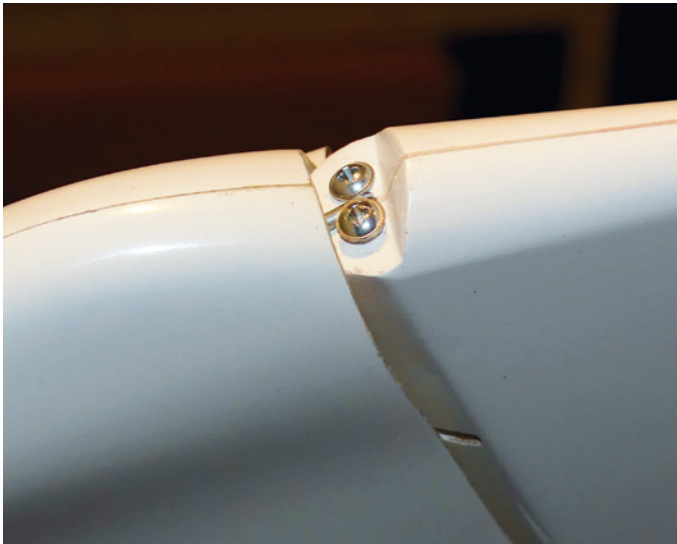
Der abgekröppte Edelstahl Draht der Seitenruderachse kann per Schrauben oder Klebeband gegen Herausrutschen gesichert werden. Im Testmodell sind dazu Alu-Schrauben eingesetzt
