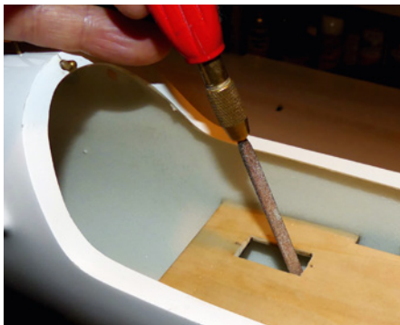
Die beiden Servo-Ausschnitte im vorgerüsteten Servobrett sind für die verwendeten D-Power-Servos minimal zu klein und mussten erst mit der Feile nachbearbeitet werden
