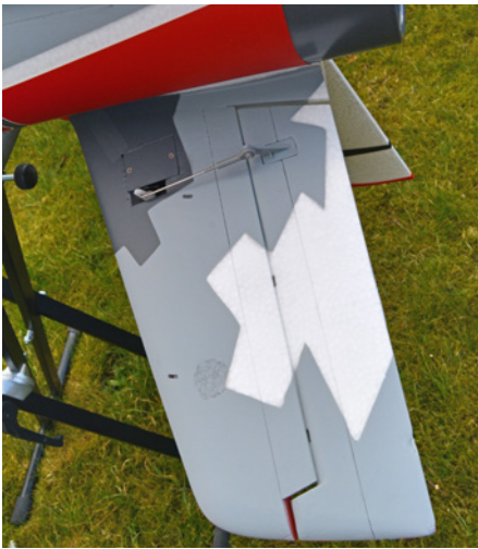
Auf kurzen Wegen werden die Ruder, allesamt in Hohlkehlen gelagert, angesteuert
