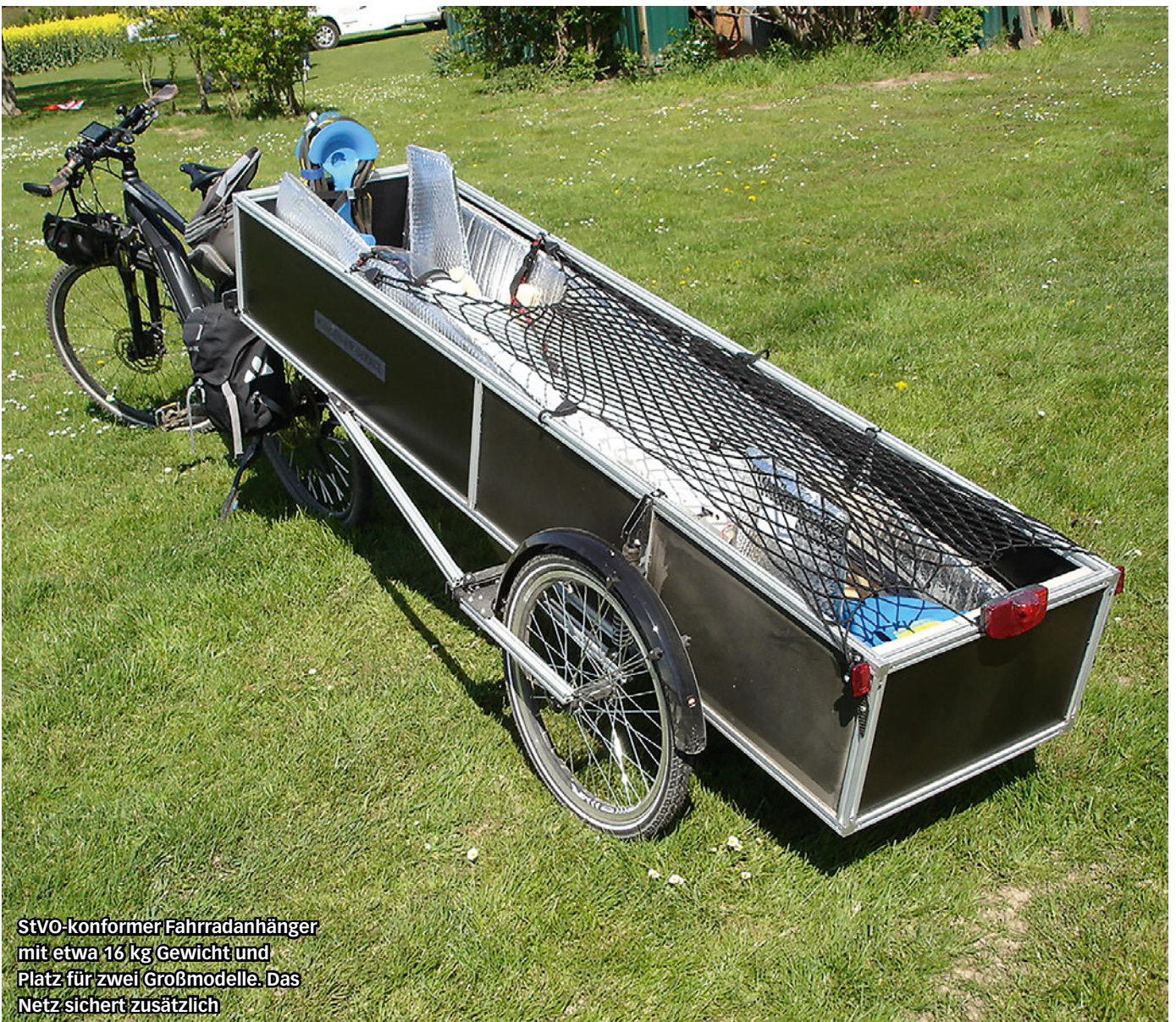
Das Fahrwerk ist am Aufbau montiert. Die Federn stammen aus dem RC-Car-Bereich
