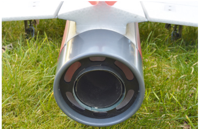
Ein einfacher, lackierter Sperrholzring nimmt das Schubrohr am Ende auf
