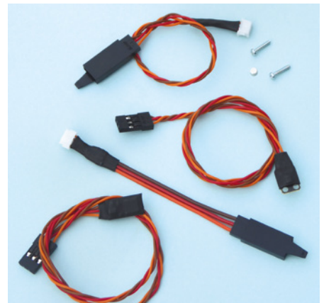
Als Zubehör können ein Temperatur- und ein Hallsensor mit Adapterkabeln optional erworben werden
