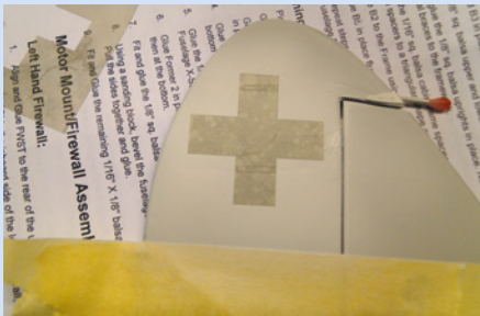
Oracal-Folie lässt sich gut lackieren. Hier sind die weiße Grundfarbe für das Schweizerkreuz bereits aufgetragen und die Schablone aus Oramask-Folie platziert
