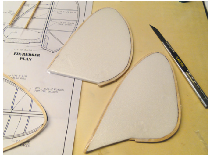
Die Außenkonturen der Leitwerke wurden über Depron-Schablonen laminiert
