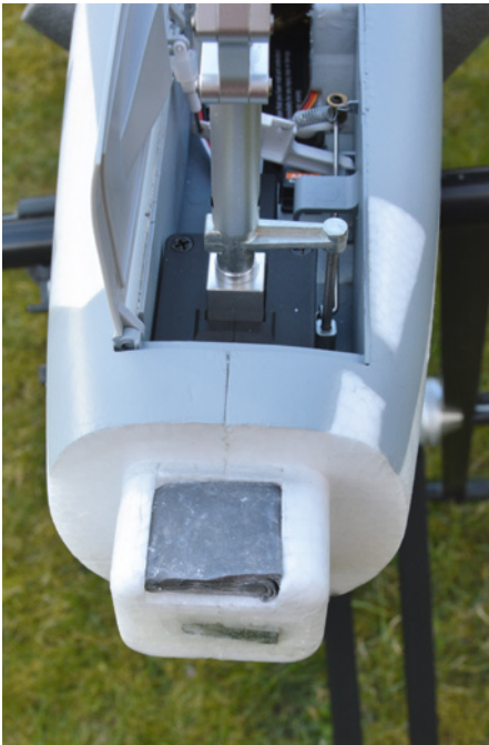
45 g Trimmblei finden innerhalb der abnehmbaren Rumpfspitze Platz, um den Schwerpunkt einzustellen
