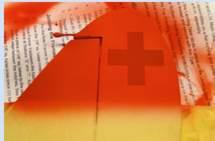
Im nächsten Schritt lässt sich die rote Farbe aufsprühen – nur der abgedeckte Bereich bleibt weiß
