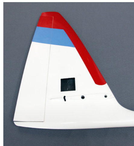
Höhen- und Seitenruder werden direkt aus dem Leitwerk heraus angelenkt. In der Seitenleitwerksflosse befinden sich entsprechende Aussparungen zum Einbau der Servos
