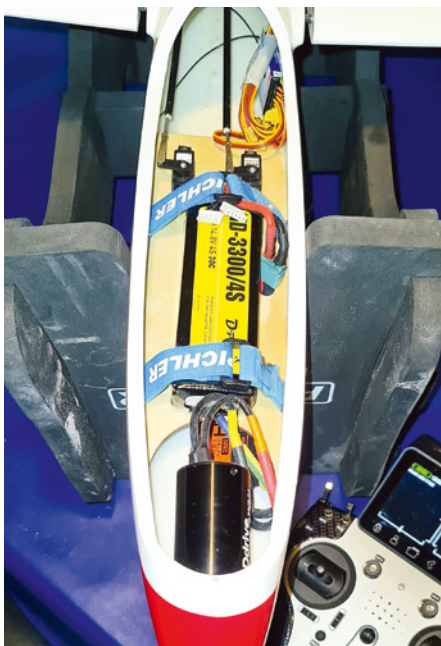
Mehrheitlich wird ein 4.300er-LiPo eingesetzt, der aber den im Text angesprochenen Heckballast zum Schwerpunkt-Ausgleich erfordert
