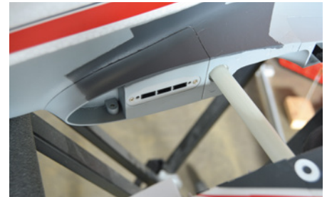
Genial gelöst: Einfach die Flächen aufschieben und fertig
