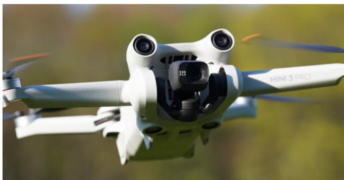
Neues Gehäuse mit Hinderniserkennungssensoren und neue Kamera mit mehr Lichtstärke und höherwertigem Sensor
