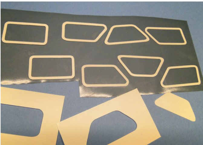
Die typischen Fensterrahmen der Dragon Rapide entstanden ebenfalls mit dem Schneidplotter
