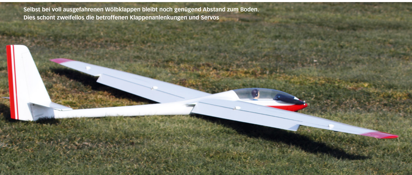
Mehrheitlich wird ein 4.300er-LiPo eingesetzt, der aber den im Text angesprochenen Heckballast zum Schwerpunkt-Ausgleich erfordert
