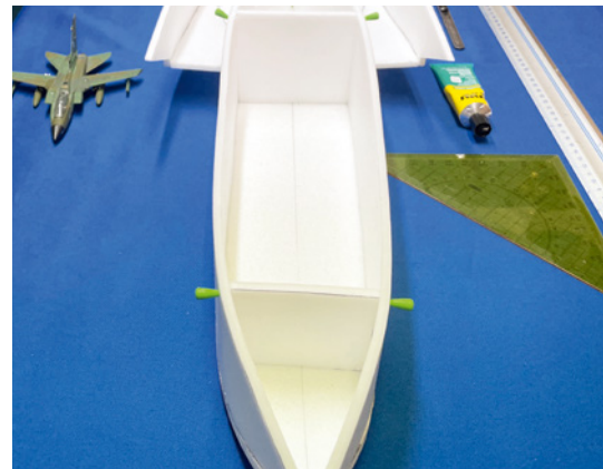
Der untere Rumpf ähnelt einem Schuhkarton. Ecken und Kanten überall. Ein wenig Arbeit mit dem Schleifpapier, um diese abzurunden, ist allerdings notwendig
