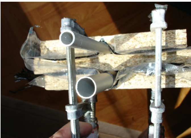
Hier werden zwei verschieden große Schellen in einem Durchgang zum Aushärten gepresst
