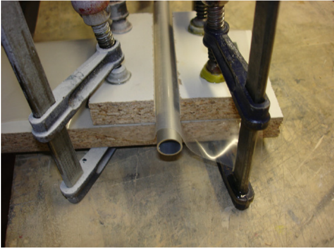
Nach dem gleichen Prinzip wie die U-Winkel entstehen auch die Befestigungsschellen zunächst mit dem Erstellen einer Urform
