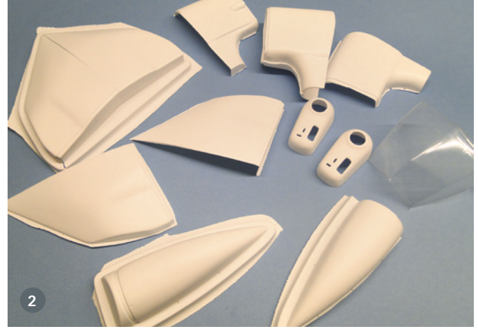
1) Nach rund 60 Stunden ist der Rohbau fertig. Die Motoren habe ich schon mal probeweise eingebaut. 2) Eine Fülle von Tiefzieh-Teilen aus Polystyrol vereinfacht den Bau von Cockpit und Motorgondeln
