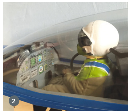
Im Inneren des Rumpfs ist prinzipiell viel Platz, aber davon beansprucht das Cockpit einiges, sodass der Antriebsakku ganz nach vorne muss
