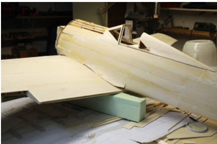
Anpassen des Flächen-Rumpf-Übergangs. Auch der Rumpf ist weiter zu schleifen und spachteln. Später folgt ein Überzug mit GFK-Matte. Die FW-190 gibt es auch in 1:4 und dafür auch einen GFK-Rumpf
