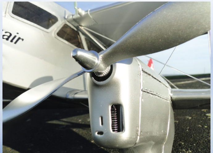
Aus einer M5-Kunststoffschraube entsteht eine einfache, schnell gemachte Zylinder-Imitation
