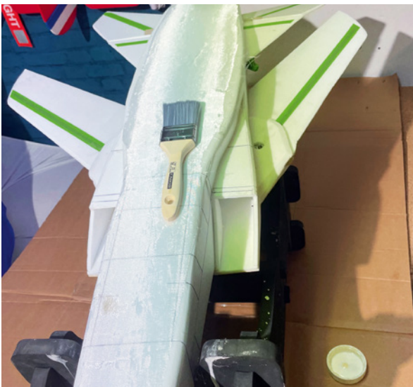
Das gesamte Modell wird zum Schutz mit Parkettlack versiegelt. Der Unterboden wurde zusätzlich mit hauchdünnem Glasfasergewebe (25 g/m 2 ) verstärkt
