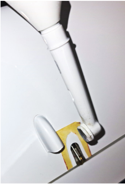
Die Gestängedurchführungen für die Klappenanlenkungen an den Tragflügeln werden abschließend mit den kleinen GFK-Hutzen verdeckt, die im Lieferumfang dabei sind
