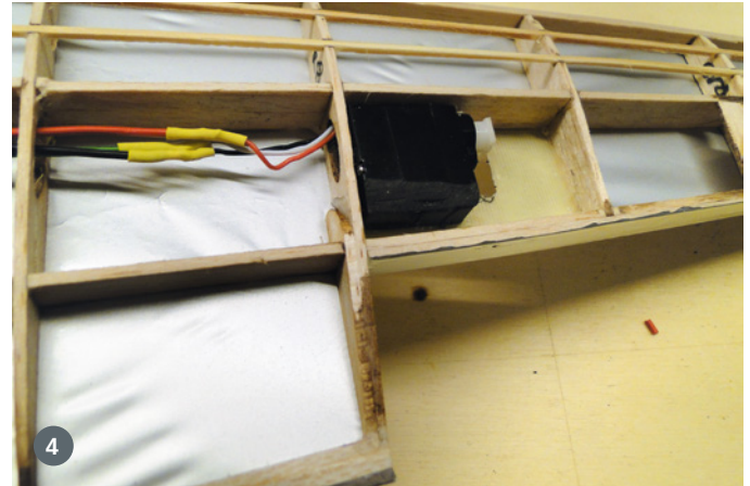
3) Die Oracal-Folie lässt sich sehr gut verarbeiten und ermöglicht eine leichte, unempfindliche Bespannung. 4) Abweichend von der Bauanleitung sind die Servos direkt vor den Querrudern eingebaut. Deren Gehäuse war im unteren Bereich etwas abzuschleifen, damit sie sich später nicht durch die Bespannung drücken
