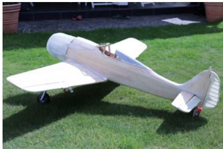
Die massive Vollholz-Bauweise ließe sich durch gezieltes Beplanken mit leichterem Balsa statt Sperrholz im Gewicht reduzieren. Für Holzmodellbauer jedenfalls ein klasse Projekt
