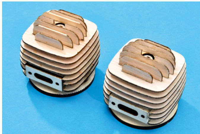
Diese selbstkonstruierte Zweizylinder-Benzinmotoratrappe war mir bisher fürs Hand-Aussägen zu lästig. Mit dem Laser hingegen ist das kein Problem
