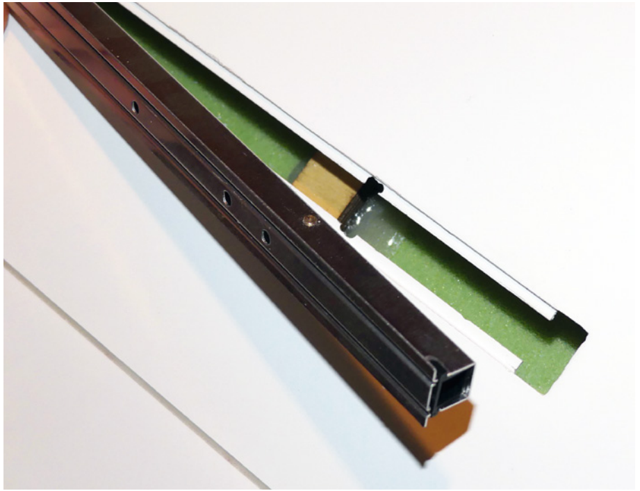
Vor dem Einsetzen der Störklappen muss zuerst der vertiefte Kleberand minimal abgeschliffen werden, damit später die weiße GFK-Klappenabdeckung bündig mit der Oberfläche des Flügels abschließt
