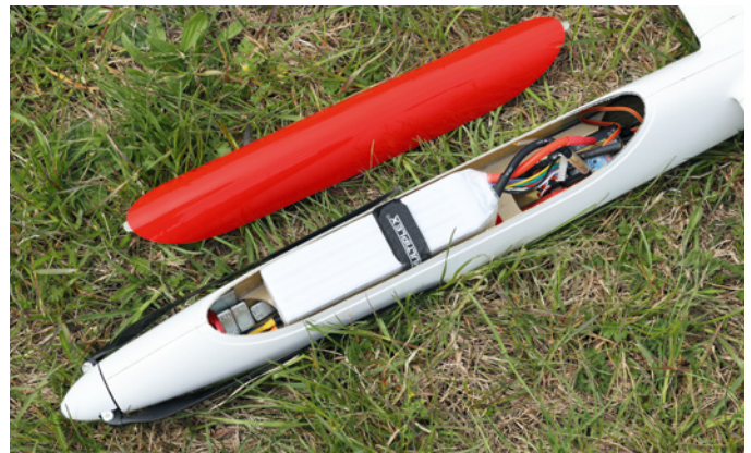
Der 6s-Antriebsakku wurde soweit wie möglich vorne platziert, um Trimmblei zu sparen
