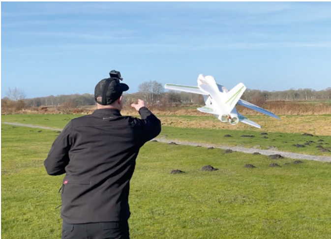
Der Start erfolgt mit \frac{3}{4} -Gas und etwa 30° Abwurfwinkel. Hierzu lässt sich der Tornado wunderbar an den Turbineneinlassöffnungen fassen
