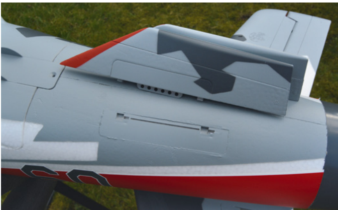
Die Stabiflossen werden einfach eingesteckt und nach hinten geschoben – das reicht und hält
