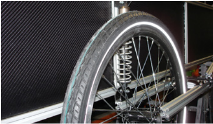
Das Fahrwerk ist am Aufbau montiert. Die Federn stammen aus dem RC-Car-Bereich
