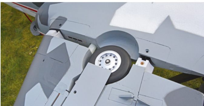
In Kunststoffträgern eingelassene Gewindehülsen aus Messing sorgen für eine langlebige Verbindung
