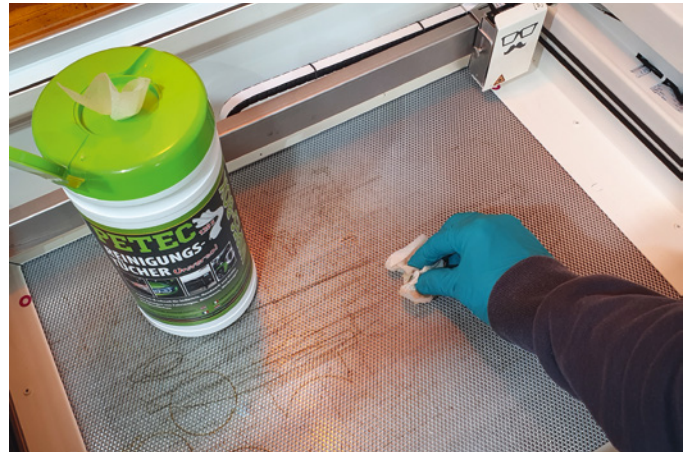
Mit Werkzeug-Reinigungstüchern lassen sich unvermeidliche Abbrand-Reste vom Gitterblech rubbeln
