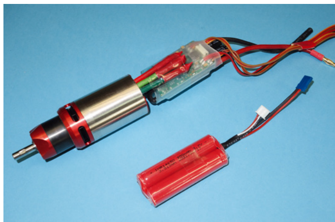
Als Antrieb kommt ein Kontronik Kira 600-22 mit Getriebe zum Einsatz. Geregelt wird er vom bewährten YGE 95 LV Regler. Unter dem Regler sitzt dann später der Backup-Empfängerakku
