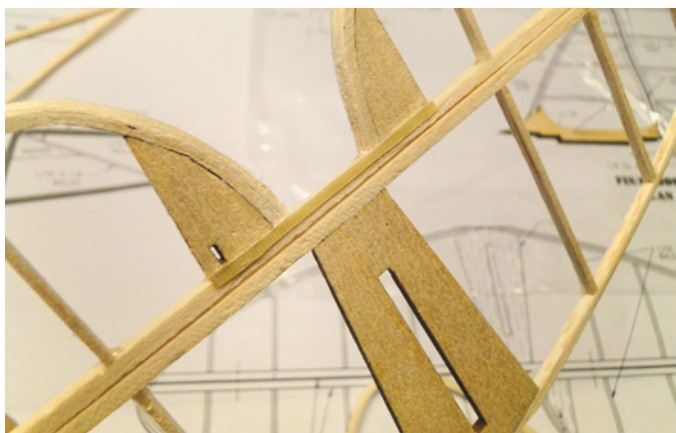
Die Verbindung der beiden Höhenruder-Hälften habe ich zusätzlich mit einem GFK-Streifen verstärkt
