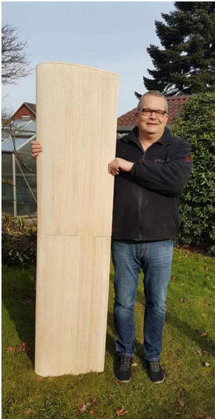
Hinter den Tragflächen könnte man sich verstecken – hier zu sehen ist die erste Version in Styro-Balsa-Bauweise
