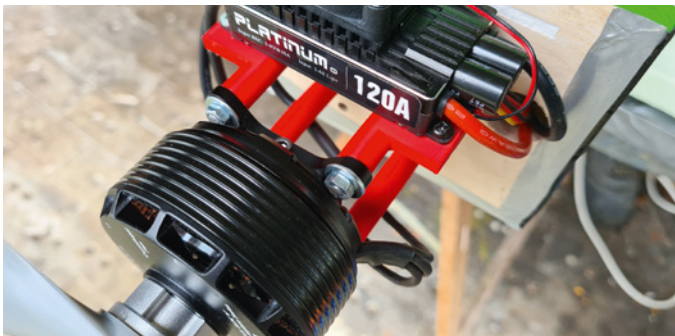
Beim ersten Entwurf war der Motor noch über Alu-Bolzen befestigt und das Ganze mit einer Haube abgedeckt
