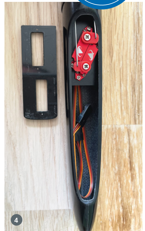
4 Schräg eingebaut ist das Ganze viel kompakter und schafft Spielraum in der Rumpfnase
