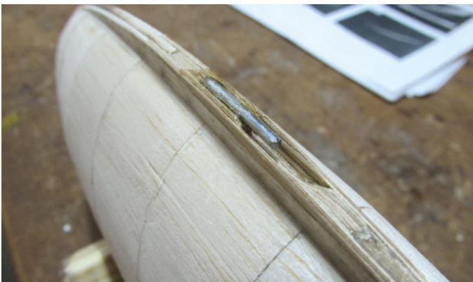
In der Landekufe ist ein Hochstarthaken versteckt
