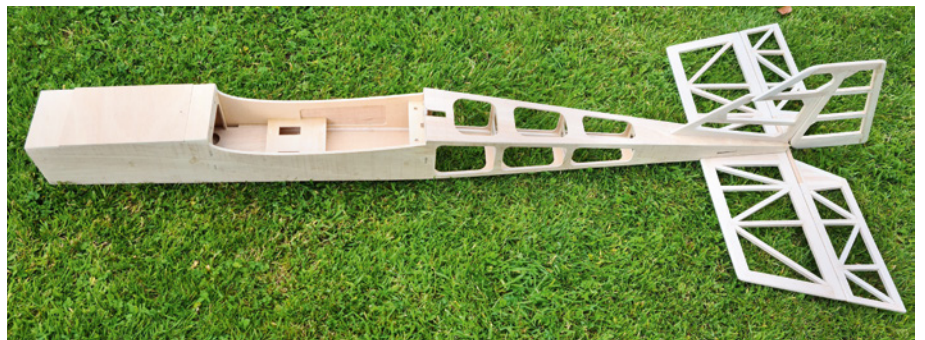
Der zweite Rumpf im Rohbau, man beachte das Leichtbauleitwerk ohne Beplankung, die erfolgte anschließend
