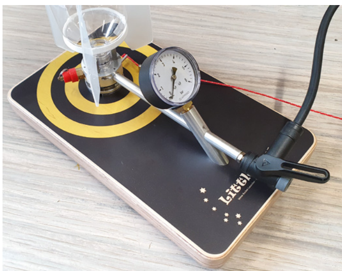
Das Manometer ist wichtig, um die Flughöhe vor dem Start abzuschätzen und den Bedingungen anpassen zu können. 4 bar reichen locker für 70 m Höhe
