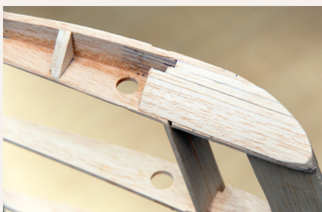
So angeschliffen ist eine größere Klebefläche für die Winglets gegeben
