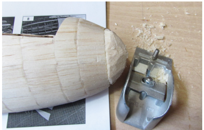
Ein Balsahobel ist beim Bau eine wertvolle Hilfe
