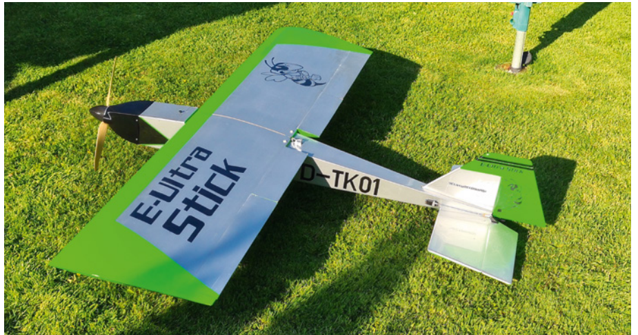
Der Prototyp Stick vor dem Erstflug. Das Konzept ging grundsätzlich auf, nur das Leitwerk war zu schwach ausgelegt
