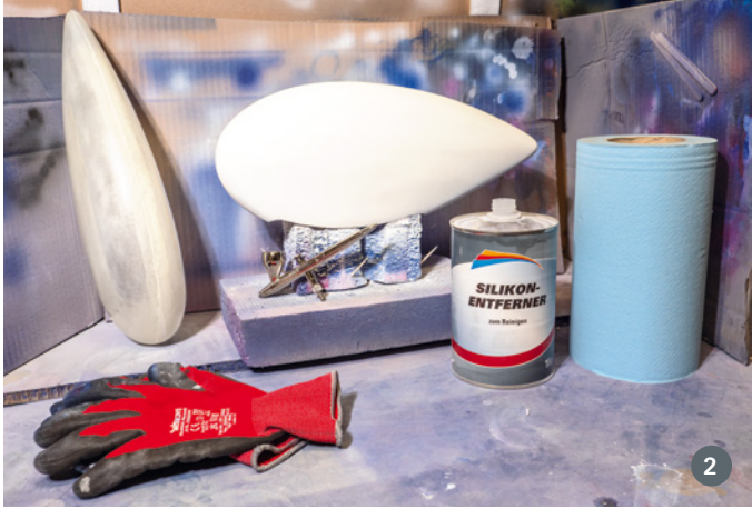
Wichtig, vor jedem Spritzgang die Oberfläche zu entfetten, zum Beispiel mit Silikonentferner
