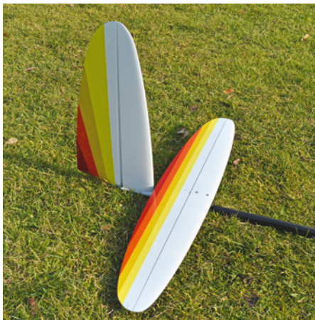
Auffällig sind die großen Ruder im Vergleich zu den Dämpfungsflächen
