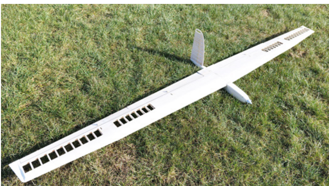
Fertiger Rohbau des 3.100 mm spannenden Holzbausatzmodells Eleganz von Der Holzflieger
