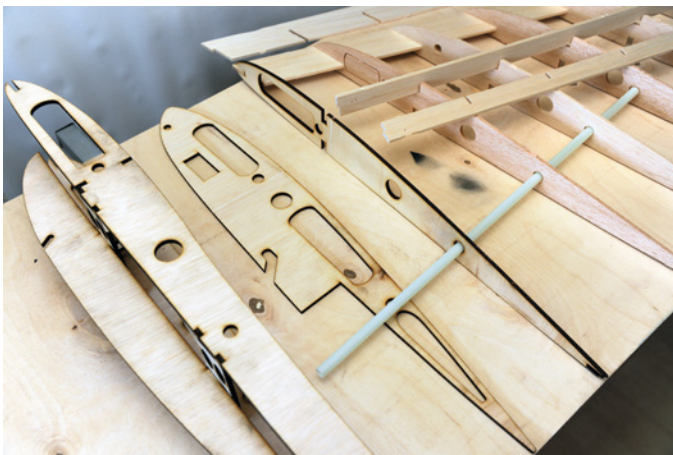
Aus Sperrholz sind die Wurzelrippen und die Kufe gefräst. Alle Teile lassen sich gut montieren und stecken
