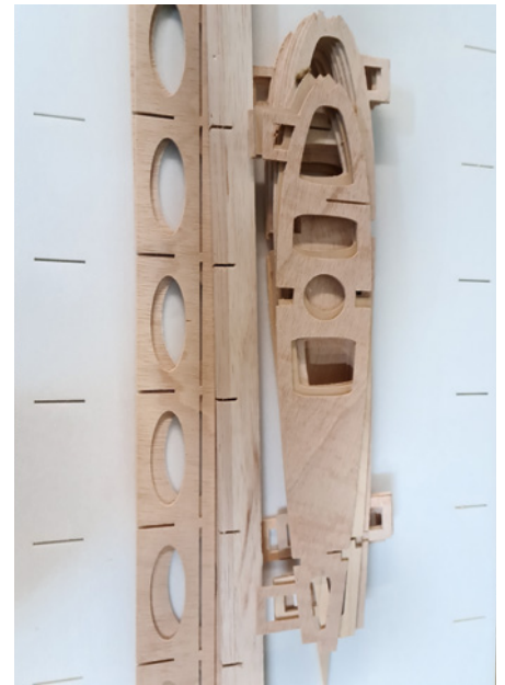
Die gefrästen Teile für die Tragfläche. Der Aufbau auf einer Depron-Helling beschleunigt den Bau
