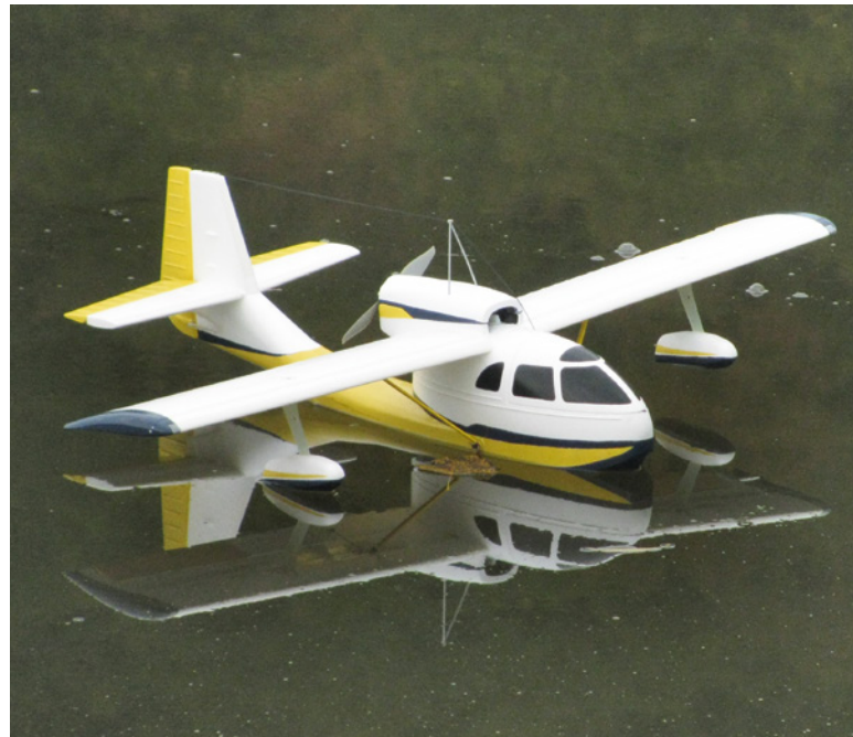
Abbildung 2: Die ehemalige Seabee von robbe ist ein typisches Wasserflugzeug mit hochliegender Tragfläche und Antriebseinheit
