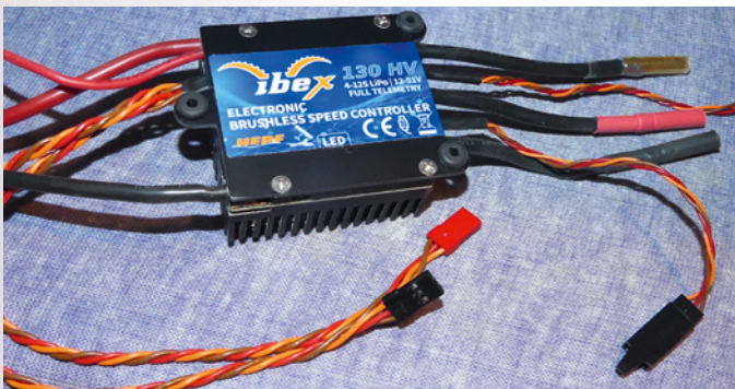
Im Testmodell wird der voll telemetriefähige IBEX 130 HV von Hepf eingesetzt, an dem alternativ ein Hall- und ein Temperatursensor angeschlossen werden können
