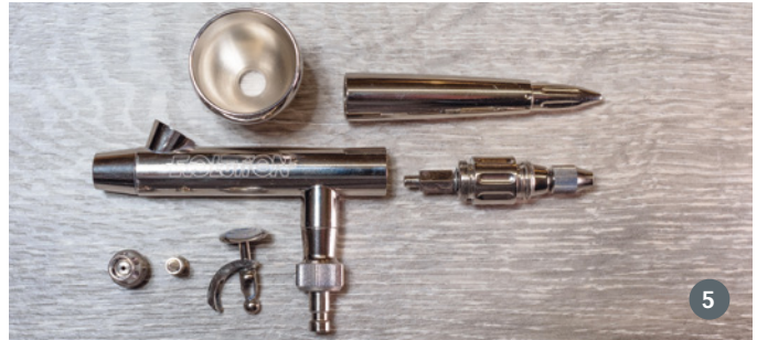
Zum Reinigen muss die Airbrush-Pistole komplett zerlegt werden. Bei guten Exemplaren funktioniert das ohne Werkzeug in wenigen Sekunden
