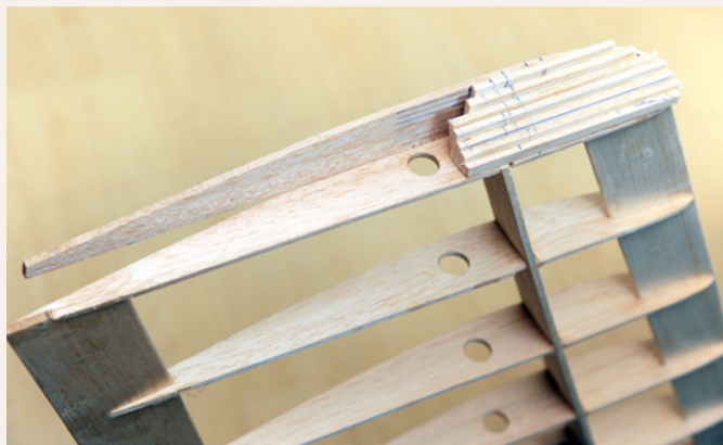
Für eine breitere Klebefläche zum Befestigen der Winglets lassen sich aus den Resten des Bausatzes Füllklötze erstellen
