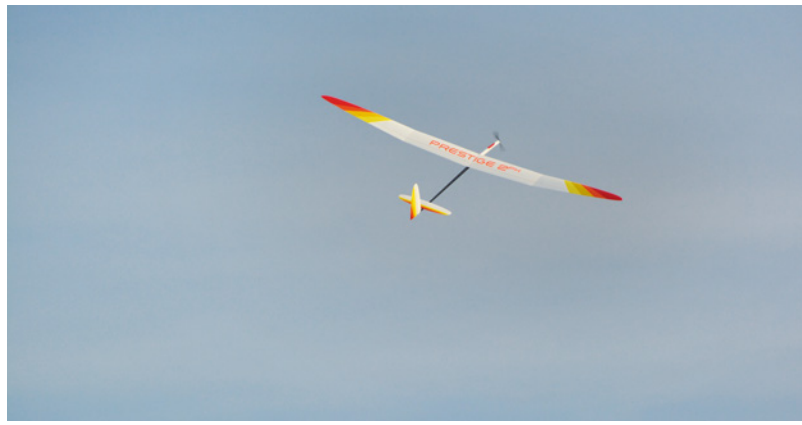
Mit Motorkraft geht es zügig auf Höhe. Bei maximal 47 A Stromaufnahme sind mehrere Steigflüge möglich
