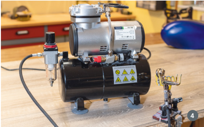
Der Kompressor Fengda FD-18 ist speziell auf die Bedürfnisse von Airbrush-Anwendungen abgestimmt. Klein, leise, regelbar und mit einem 3-l-Drucklufttank ausgestattet, der für einen konstanten Druck sorgt
