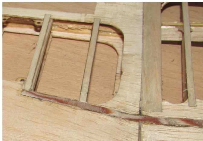
Der Möwenknick wurde an der Unterseite am Holmgurt verstärkt
