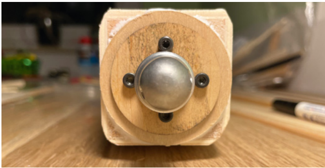
Der Motorspant wurde aufgedoppelt und bietet damit mehr Volumen für den späteren Zuschliff
