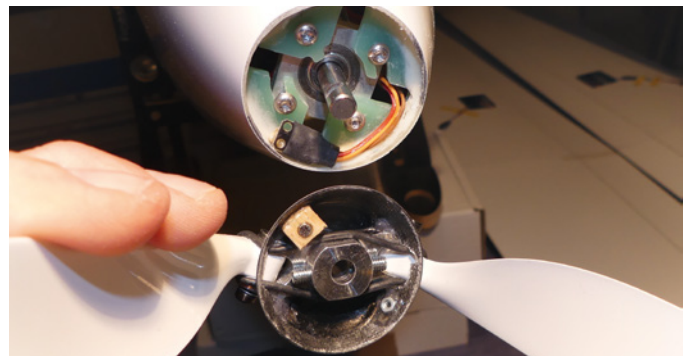
Der Hallsensor dient der Propellerpositionierung. Er wurde hochkant und nahe dem Spinner vor dem Motorträger verklebt. Der kleine Gebermagnet ist seitlich im Spinner verklebt. Als Gegengewicht dient eine etwa gleichschwere Mutter
