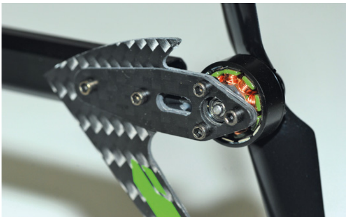
Der drehzahlgesteuerte Heckrotor besitzt seinen eigenen Außenläufer
