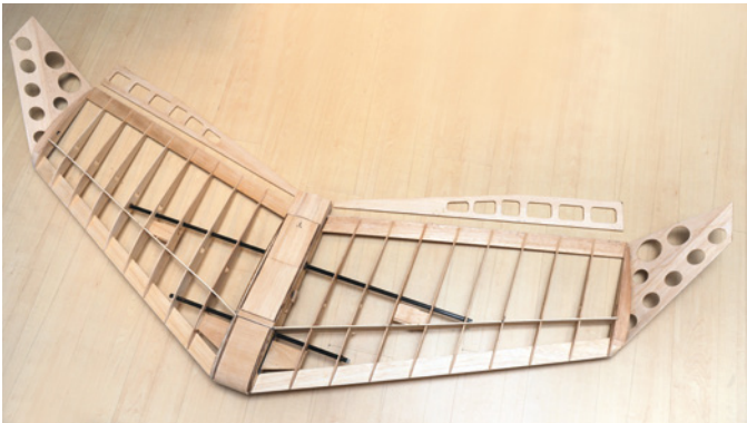
Der abgeschlossene Rohbau erstmals montiert. Nach dem Behandeln mit G4 wird foliert
