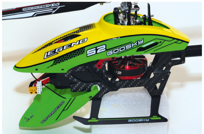
Die vorne zweigeteilte Haube ermöglicht einen komfortablen Wechsel des Antriebsakkus
