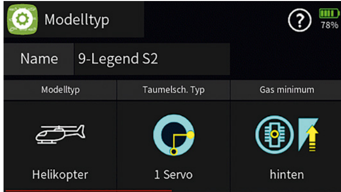
Die Programmierung des Senders beginnt mit der Auswahl des Modelltyps Helikopter, Taumelscheiben-Typ 1 Servo und Gas Minimum nach persönlichem Vorzug
