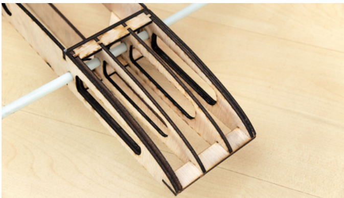
Der normale Fronteinschub ist zugleich der spätere Akkuträger
