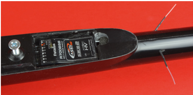
Die Aufnahmekammer für den Empfänger. Die Antennen müssen herausgeführt werden
