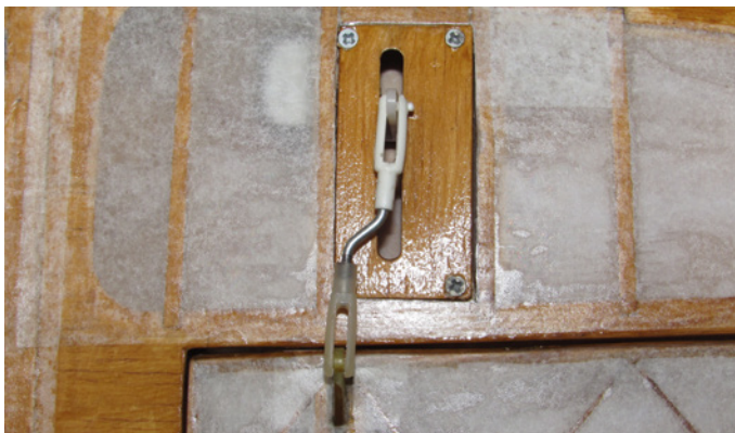
Der Versatz der Ruderhörner passt nicht zum durchdachten Eindruck des Bausatzes wurde aber einfach mit einer Z-Biegung gelöst
