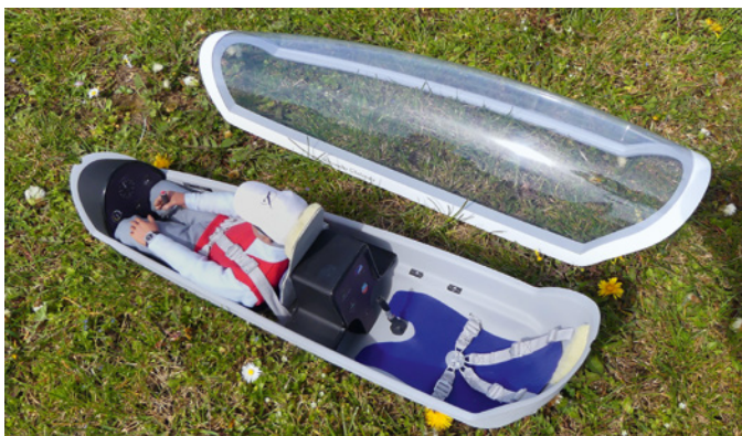
Einen beachtlichen Zeitvorteil beim Aufbau des Duo Discus bringt die fertig auf den GFK-Rahmen aufgezogene Kabinenhaube mit weiß lackiertem Rand und fertiger Verriegelung
