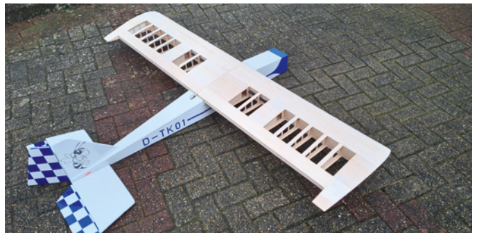
Das Leitwerk beim zweiten Modell ist vollständig beplankt, die Fläche hingegen in großen Bereichen
