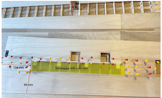
Nicht vorgesehen, aber möglich, ist der Einbau einer Bremsklappe nach eigenen Vorstellungen. Optimal ist leichtes sowie steifes GFK-Plattenmaterial
