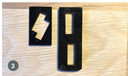
3 Rechts das eigentlich vorgesehene Servo-Brett für die klassische Platzierung, links eine Alternative
