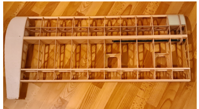
Eine Tragflächenhälfte (noch) ohne Beplankung. Der Randbogen ist nach wie vor aus Styropor geschnitten und wird mit beplankt
