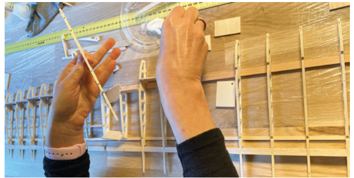
Verkleben der Rippen mit Weißleim. Die Passgenauigkeit der Frästeile ist sehr gut
