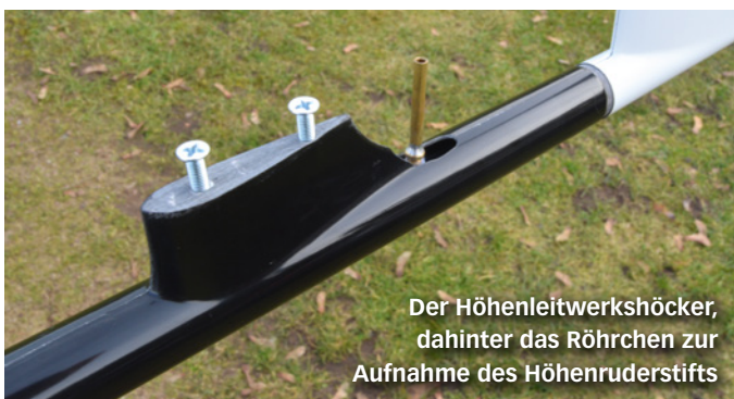
Die saubere Verarbeitung sorgt für einwandfreie Passgenauigkeit. Gut erkennbar ist auch die Multiplex-Kontaktierung
