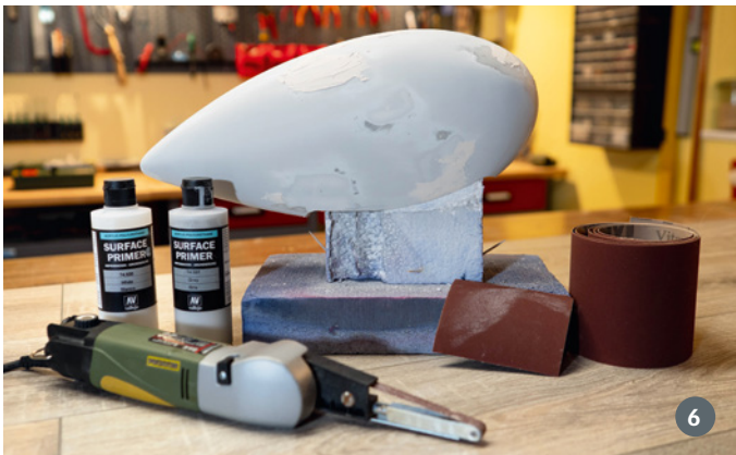
Vorbereitung ist alles. Wer sich beim Spachteln, Schleifen und Grundieren Mühe gibt, wird später auch ein gutes Lackierergebnis erzielen
