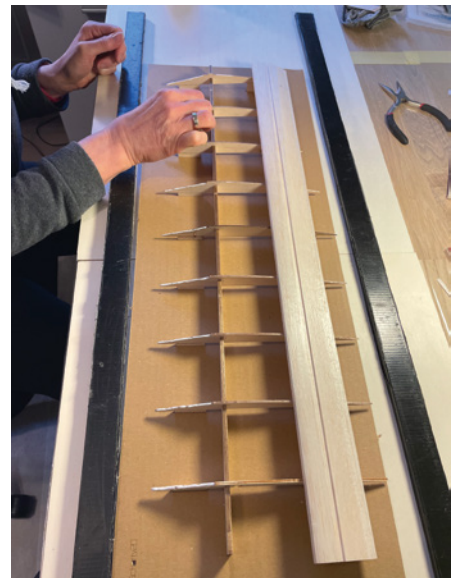
Eine Papphelling und ein Rippenkamm helfen beim Bau der Jedelsky-Fläche
