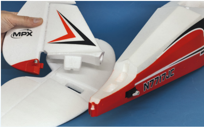
Über Zapfen und eine Nylonschraube werden beide Leitwerke mit dem Rumpheck verbunden
