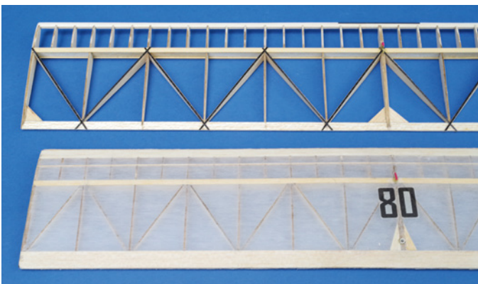
Bauweise B: Nasen- und Endleiste als 1-mm-Balsa-Streifen oben und unten. Carbon-Streifen auf den Diagonalen erwiesen sich als überflüssig
