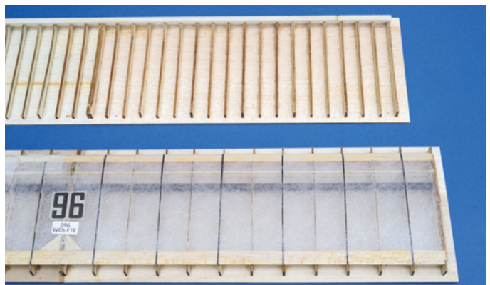
Bauhellingen auf 2-mm-Paulownia-Furnier. Ausreichend leichte Rohrholme sind schwer zu finden, vereinfachen aber den Aufbau
