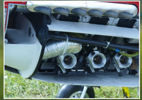
Die selbst hergestellten GFK-Formteile gewähren maximalen Platz für den Motoreinbau
