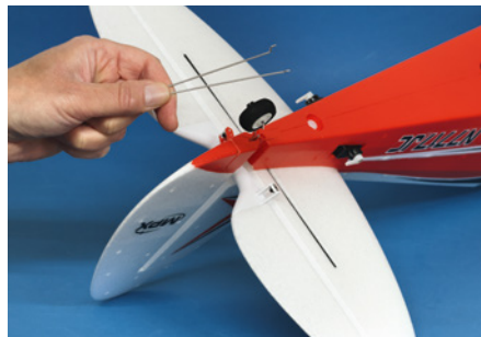
Ist das Spornrad montiert, können die Lenkstangen eingesetzt werden. Über den Einhängpunkt gibt die Anleitung Auskunft
