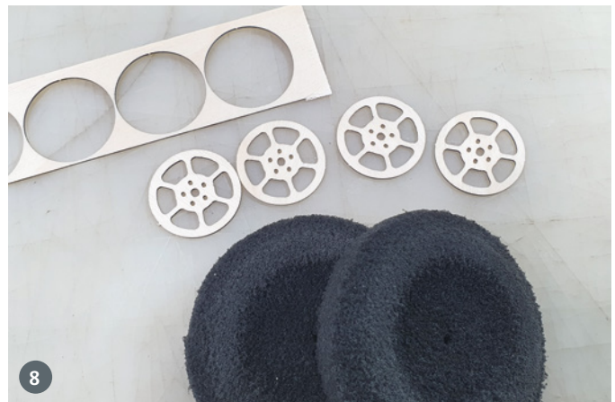
8 Die passenden Felgenscheiben sind im Konstruktionsprogramm rasch als DXF-Datei erstellt. Ihre Aussparungen dienen hauptsächlich der Optik, aber auch der Gewichtseinsparung
