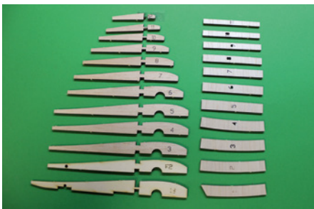
Neben den Rippen gehören auch gelaserte Teile der Verkastung zum Lieferumfang. Sie unterstützen, dass der Flügel seine geschwungene Form behält
