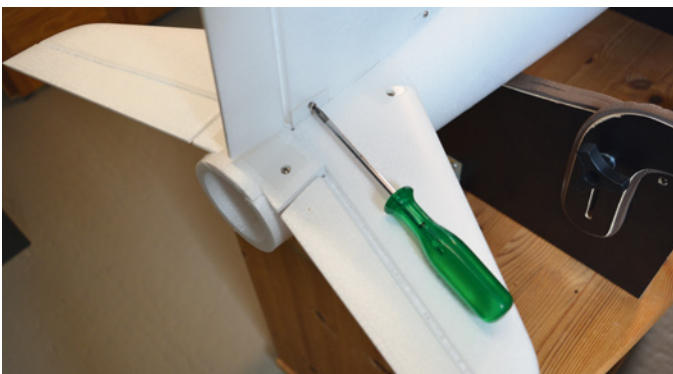
Viel Festigkeit erzielt der Aufbau durch Verwenden von Schraubbefestigungen
