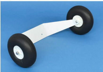
Massiver Alubügel und Ballonreifen. Das alles ist sehr leicht und stabil, aber federt leider kaum
