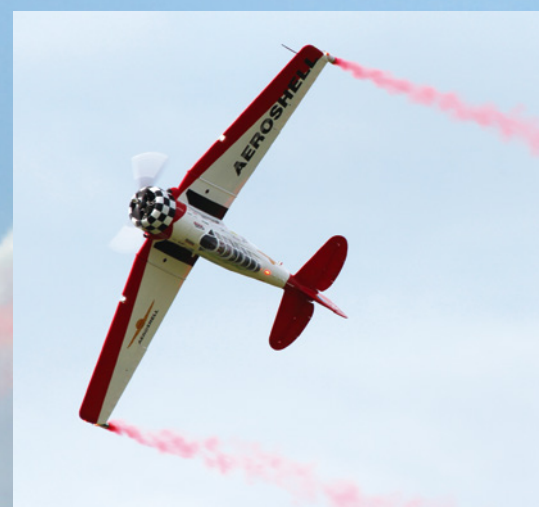
Mit gleich drei AT-6 Texan von CARF-Models in AeroShell-Lackierung flogen Piloten des CARF-Teams im Verbandskunstflug. Die verbauten Fünfzylinder-Sternmotoren Moki 250 sorgten für eine ansprechende Klangkulisse
