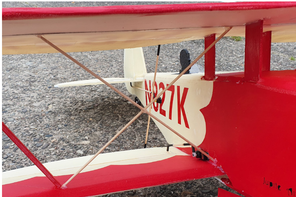
Die diagonalen Holzstreben sind an Rumpf, Flügel und im Kreuz verklebt, was viel zur Stabilität beiträgt. Die Depronstreben sorgen lediglich für eine stimmige Optik
