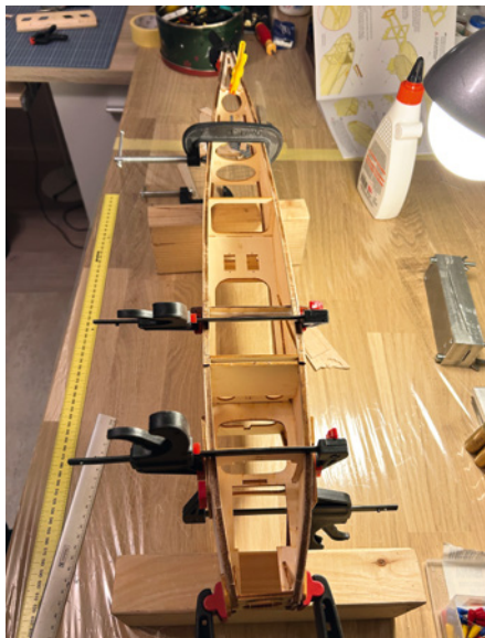
Klemmen fixieren die Seitenteile beim Aushärten des Klebstoffs
