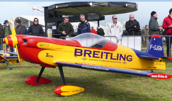
Den Maßstab-Hammer der ProWing flog eindeutig Jan Rottmann, nämlich die zulassungspflichtige 1:1,6 Delro Cap 232 aus dem eigenen Haus mit 4.500 mm Spannweite, 76 kg Abfluggewicht, 684-cm3-Boxer von 3W und 18 Savöx-Servos 2290
