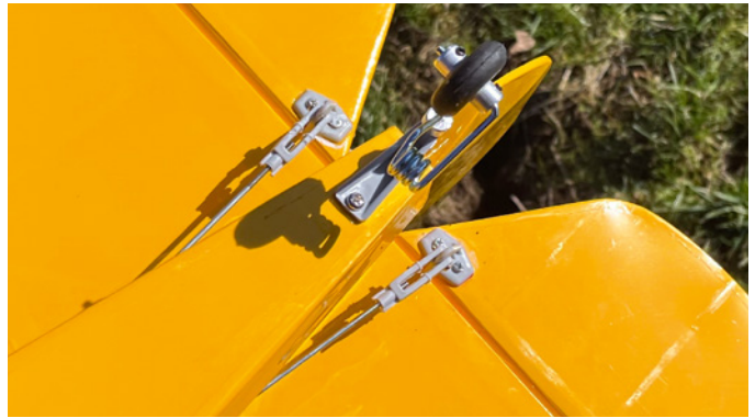
Alle zur Anlenkung der Ruder erforderlichen Teile liegen bei. Die Ruderhörner werden an die Ruderklappen geschraubt
