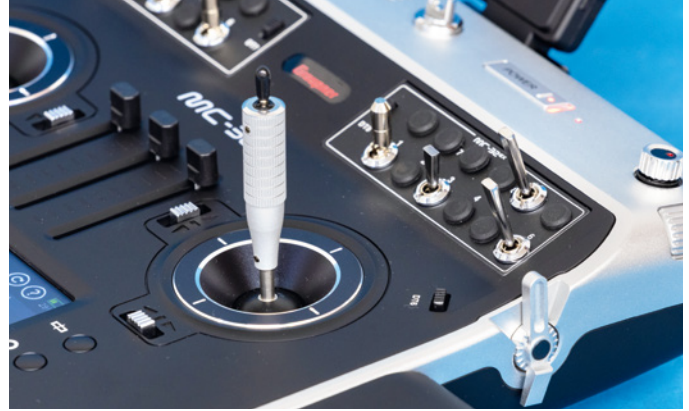
Präzise, fein auflösende, Alu-Kreuzknüppel mit Hallsensoren und integrierten Schaltern zeichnen die mc-32ex aus
