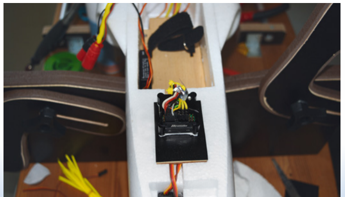
Ein noch vorhandener Cortex-Kreisel stabilisiert gut – ist aber kein Muss
