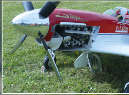
Alle hochglänzenden Alu-Teile sind mit Folie aufgebracht – einschließlich Propeller und Spinner
