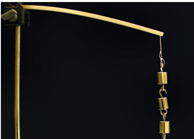
Bild 4: Ein Biegeversuch mit einem dünnen und einem dicken Balken. Von einer geringen Menge sehr leichtem Stützmaterial abgesehen, haben beide Balken die gleiche Masse, aber eine signifikant andere Durchbiegung
