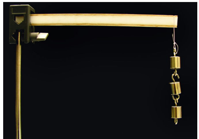
Bild 4: Ein Biegeversuch mit einem dünnen und einem dicken Balken. Von einer geringen Menge sehr leichtem Stützmaterial abgesehen, haben beide Balken die gleiche Masse, aber eine signifikant andere Durchbiegung
