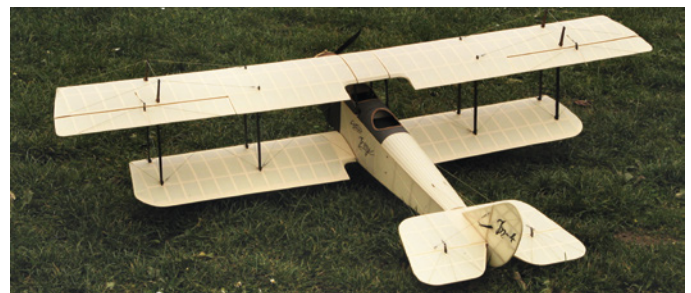
Bild3: Die Curtiss Jenny war ein typisches Beispiel für eine Auslegung mit einem sehr dünnen Profil und starker Flächenverstreubungen mit Seilen
