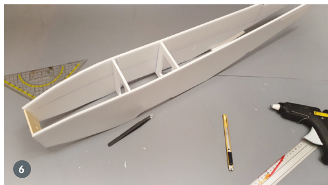
1) Die Sternmotorattrappe ist nur ein ausgedrucktes und dann laminiertes Foto – aus etwas Distanz eine tolle optische Täuschung. 2) Vom Buschtrottler hat Jupiter Bipe einiges übernommen – unter anderem die Ballonreifen der Multiplex Funcub. 3) Nur drei Spanten braucht dieser einfache Rumpf – zwei aus Depron, einer aus Holz. 4) Die Spanten werden zunächst auf eine der beiden Seitenwände exakt senkrecht geklebt. 5) Sehr schnell entsteht aus wenigen Bauteilen die Rumpfstruktur. 6) Beim Einkleben des Motorspans sind Seitenzug und Motorsturz zu berücksichtigen
