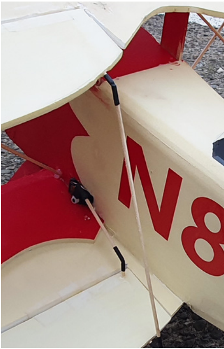
Die Flaperons von Ober- und Unterflügel werden mit einfachen Schubstangen gekoppelt
