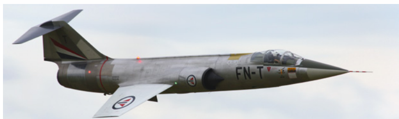
Aus Norwegen reiste Trond Hammerstad mit seinem bis ins Detail absolut scale ausgebauten, lackierten und beschrifteten F-104 Starfighter (Airworld-Modell) an. Das 1:3-Modell mit 2.500 mm Spannweite und 5.780 mm Länge wiegt 70 kg und erreicht 380 km/h
