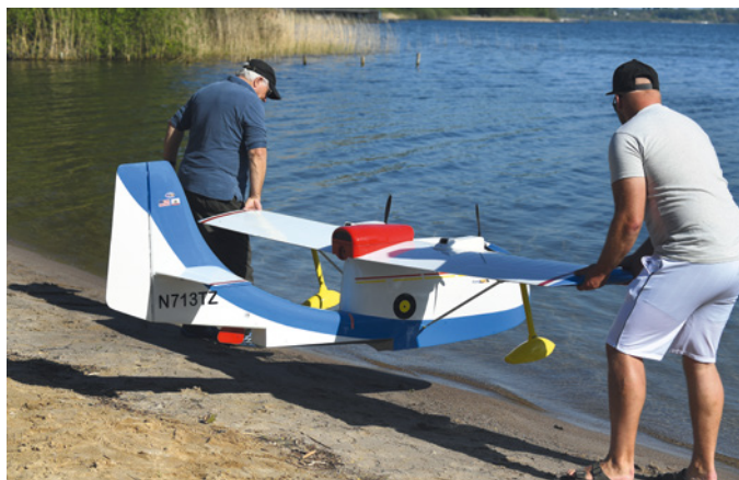
Die über 2 m spannende Seabee baute Thomas Zipperle von Heckantrieb auf Zweischaubenzugantrieb um – jetzt ist sie erheblich leiser
