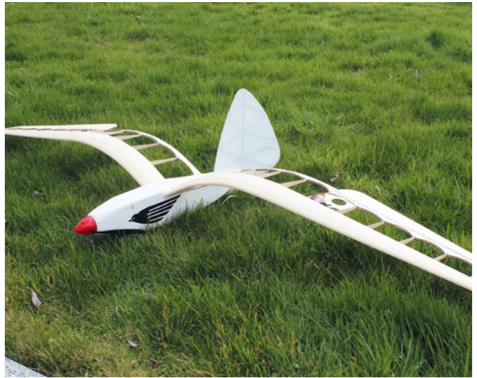
Rumpf und Leitwerk sind bespannt. Die Flügel zu bespannen ist nicht trivial, aber auch kein Hexenwerk
