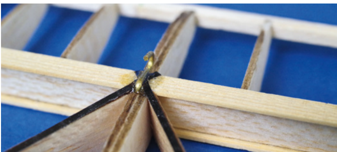
Beide Abbildungen verdeutlichen die Bauweise A. Nasen- und Endleiste aus 2 mm Balsa stecken in Rippen-Schlitzten
