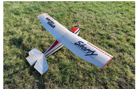
Von oben betrachtet lässt nichts auf die offene Rippenbauweise der Fläche schließen
