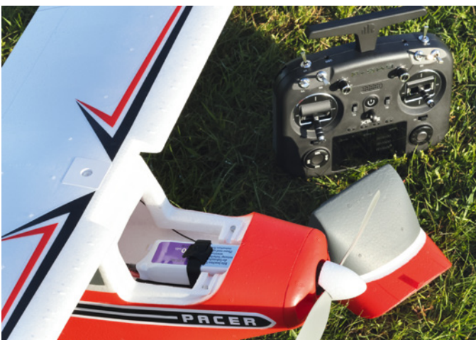
Zugang zum Akkuschaft über die Kabinen-Motorhaube. Ideal sind 3s-LiPos mit 2.200 mAh Kapazität
