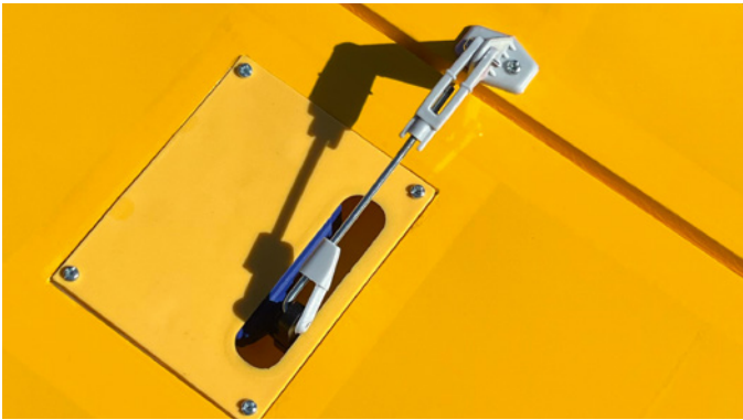
Die Anlenkung der Querruder erfolgt über zwei Servos, die an den Deckeln verschraubt sind
