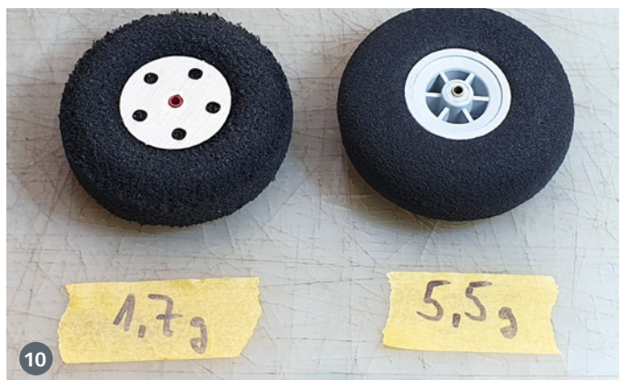
10 Ein derart selbstgebautes Schaumstoff-Rad ist stets leichter als die leichtesten käuflichen Moosgummi-Exemplare. Wer auf jedes Gramm schauen muss, der findet hier Sparpotenzial
