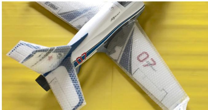
Schaum-Modelle sind empfindlich, deshalb erstelle ich mir Schutztaschen aus Luftpolsterfolie, die mit einem Folienschweißgerät, normalerweise für Gefrierbeutel verwendet, zu Taschen verarbeitet wird
