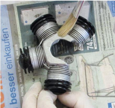
Nach dem Lackieren mit der Spraydose muss die Attrappe noch treibstoffresistent werden
