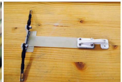
Um Klappen mechanisch mitzunehmen und auf dem Wege den Betrieb zusätzlicher Servos zu sparen, sind Halterungen und Mechaniken an den Klappen in Eigenbau zu erstellen
