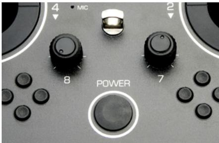
Mittig sind der Schalter mit Status-LED, zwei Drehgeber, ein Mikrofon und die Öse für den Gurt platziert
