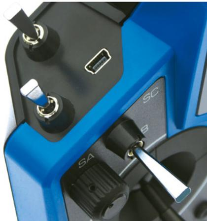
Links vom Display befinden sich drei Schalter, ein Drehgeber, sowie der USB-Port
