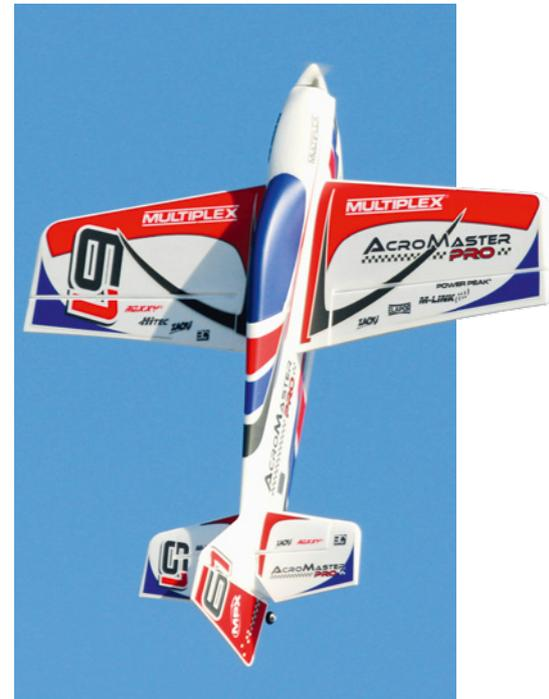
Hover- und Torquefiguren gelingen dank der großen Ruderflächen auf Antrieb. Der Antrieb ist stark genug, den AcroMaster Pro aus jeder Lage zügig und senkrecht nach oben zu beschleunigen
