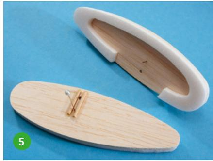
5. Indem wir mit einer Stecknadel von der Außenseite exakt gerade zwischen den Rundhölzern durchstechen, erzeugen wir eine von der Innenseite gut erkennbare Markierung. Genau mittig zwischen die Hölzer, denn der Rundmagnet, mit dem die Radschuhe später am Stahldraht gehalten werden, hat seine maximale Haltekraft in seinem Kreiszentrum
