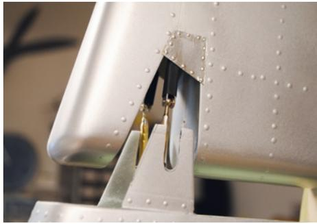
**In Hohlkehlen gelagert ist beispielsweise das Seitenleitwerk. Darum ist vor dem Setzen des Ruderlagers die komplette, innenliegende Anlenkmechanik fertigzustellen. Technisch und optisch eines von vielen Highlights des Bausatzmodells**
