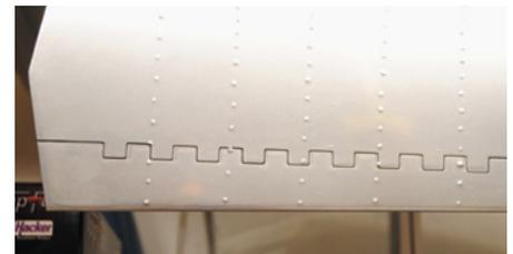
Die Mischung aus Vertiefungen in der GFK-Form und nachträglich aufgebrachte „Spaltschatten“ hinterlassen einen realistischen Eindruck bei den Trimmklappen
