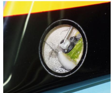
Das Höhenruderservo steuert das Höhenruder auf direktem Weg per Stahldraht an
