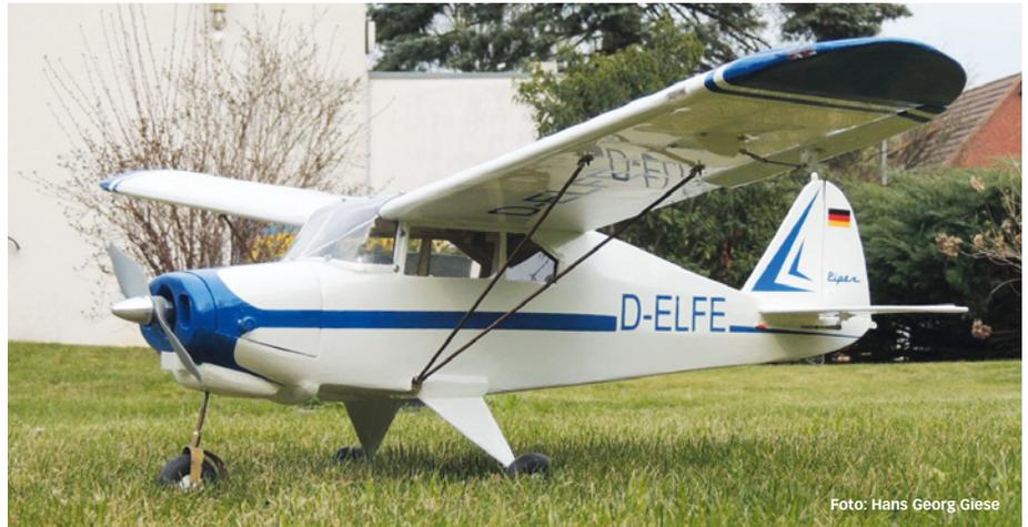
Die Graupner Tri Pacer aus dem Schnellbaukasten-Angebot der 1960er-Jahre, ein nettes kleines Modell mit einer Spannweite von 1.110 mm
