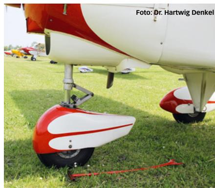
Optional wurden die Tri Pacer damals mit aerodynamisch sauberen Radverkleidungen ausgeliefert, diese Radschuhe gab es mindestens in zwei Ausführungen
