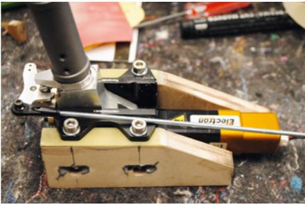
Für die Fahrwerke waren in diesem Fall noch Befestigungen selbst zu erstellen, doch bei aktuellen Bausatzausführungen ist das alles seitens des Herstellers optimal vorbereitet, da von ihm künftig auch exakt passende Fahrwerke angeboten werden
