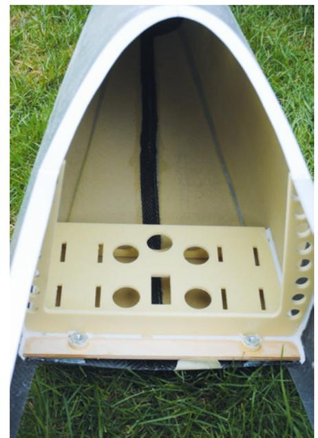
**Ab Werk sind einige Verstärkungen und Spanten eingeklebt**
