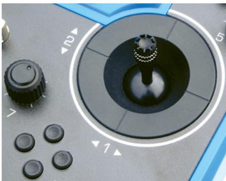
Die präzisen Steuerknüppel bestehen aus Kunststoff, die Trimmung wird durch vier Tasten realisiert
