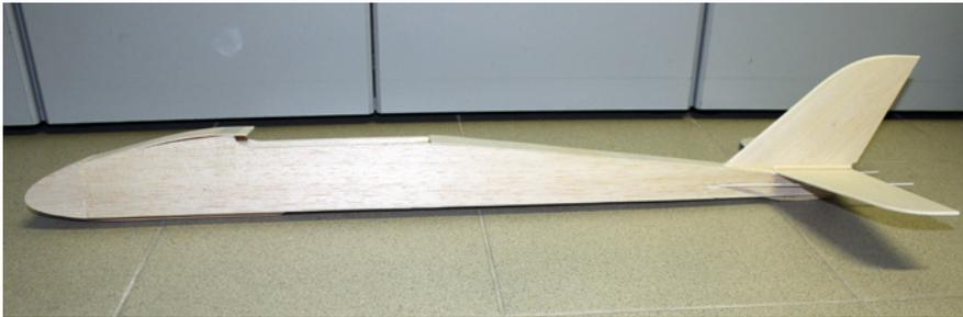
**Der Rumpf ist im Rohbau fertig. Die einfache Kastenkonstruktion sorgte für eine zügige Fertigstellung**
