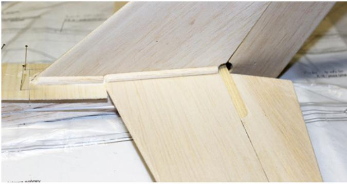
**Verstärkungsleisten am Seitenleitwerk sichern das Konstrukt**
