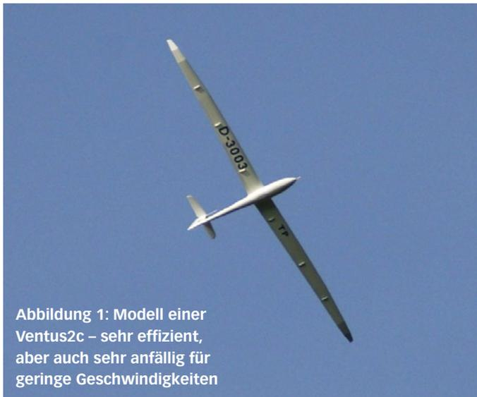
Abbildung 1: Modell einer Ventus2c – sehr effizient, aber auch sehr anfällig für geringe Geschwindigkeiten
