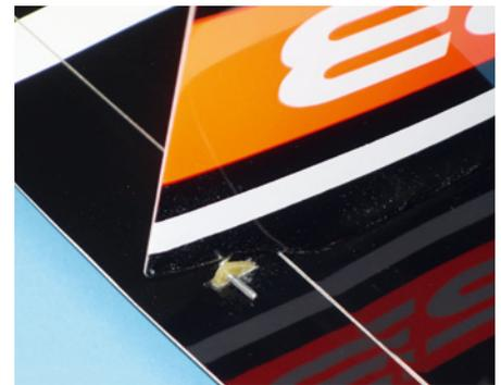
Ruderseitig wird der Anlenkungsdraht nur um 90 Grad abgewinkelt und dann durch das GFK-Ruderhorn gesteckt
