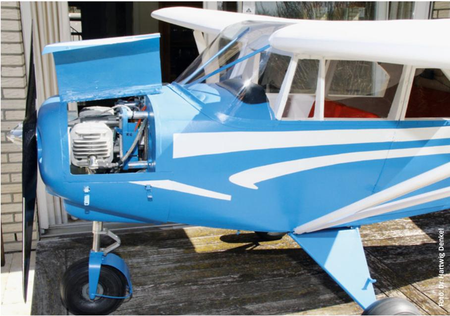
Originalgetreu sind auch die Klappen an der Cowling als Zugang zum Triebwerk umgesetzt, nur das beim Modell ein Valach 85 Boxer eingebaut ist
