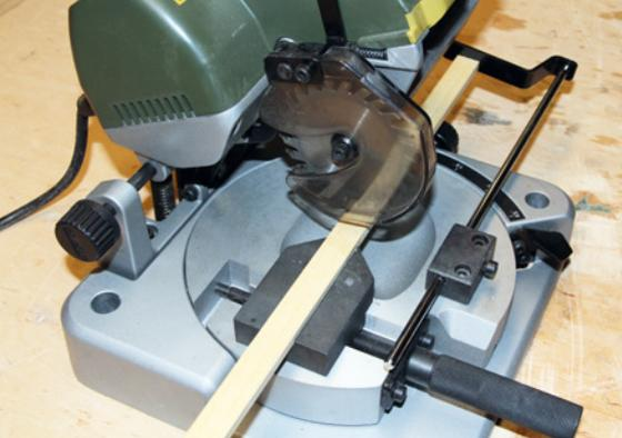
Ein Werkstück ist eingeklemmt, der Anschlag dient zur Längenbestimmung
