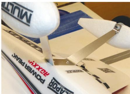
Wo beim Ur-AcroMaster noch ein dürres Drahtfahrwerk wackelte, sitzt nun ein eloxiertes Alu-Bügelfahrwerk bester Qualität
