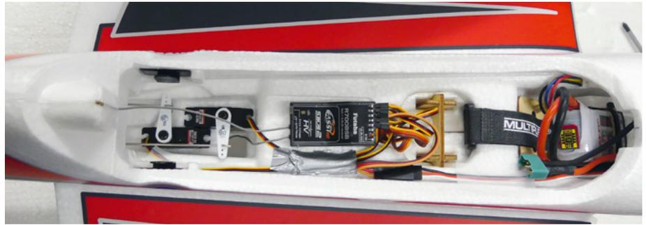
Der Rumpf bietet für die Einbauten genügend Platz. Wird ein Kreisel verbaut, kann er an der Stelle befestigt werden, an der hier der Empfänger sitzt. Letzterer ließe sich dann seitlich an der Rumpfwand befestigen. Der Akku-Schlitten aus Sperrholz ist in der aktuellen Version per Klettband gesichert
