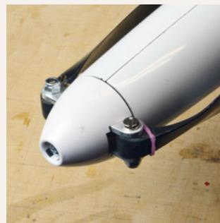
**100 Passgenaue Motoraufnahme für Elektrosegler**
