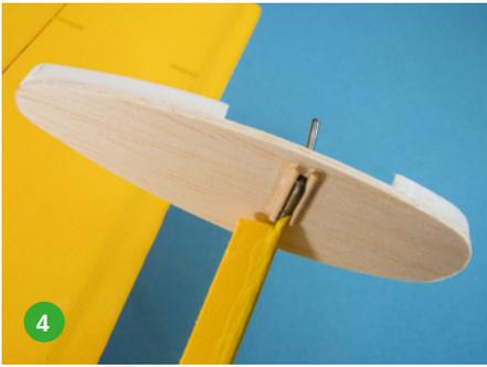
4. Genau dort kleben wir zwei Rundhölzer im Durchmesser des Fahrwerksdrahts seitlich an, sodass dieser exakt dazwischen passt. Hierbei können wir letztes Augenmerk darauf richten, dass beide Radschuhe wirklich identische Ausrichtung besitzen und nicht etwa einer „hängt“. Den Draht aber noch nicht festkleben, es geht weiter!
