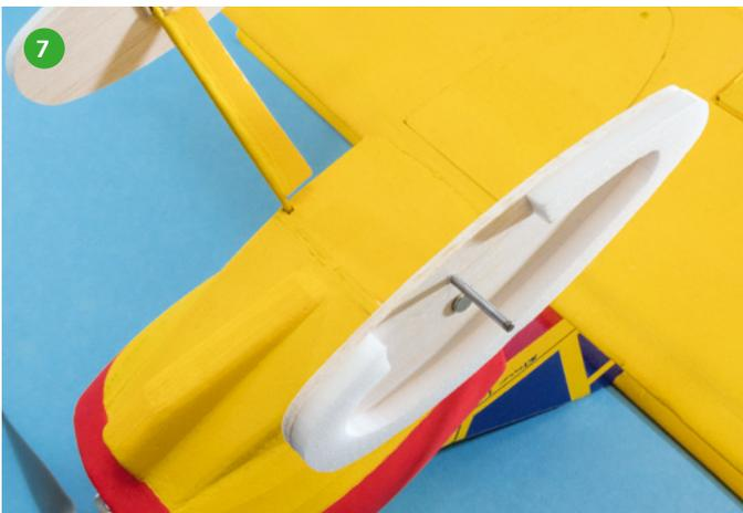
7. Nun sind beide Innendeckel mit der Magnet-Aufnahmebohrung versehen. Der Magnet ist mit Sekundenkleber so eingesetzt, dass er mit dem Fahrwerksdraht direkten Kontakt bekommt. Er ist hier mit 4 mm Zylinderhöhe etwas dicker als das 3 mm starke Balsa. Deshalb ragt er innen etwas hervor, was das Rad aber nicht weiter behindert
