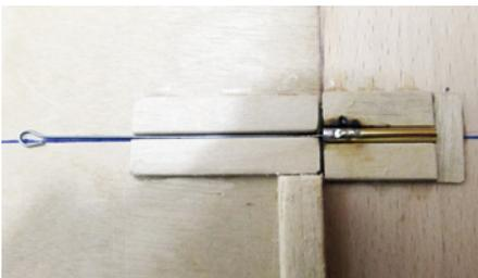
Der untere Teil der Abspannung entsteht in einer einfachen Helling
