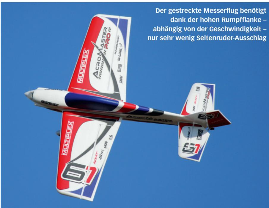
Der gestreckte Messerflug benötigt dank der hohen Rumpfflanke – abhängig von der Geschwindigkeit – nur sehr wenig Seitenruder-Ausschlag
