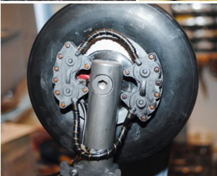
Wer sich in die Umsetzung von Details verlieren möchte, findet auch bei den Fahrwerken selbst ein großes Feld. Hier wurden selbst die Bremsen als Attrappen imitiert. Zusammen mit ein paar „Schläuchen“ und blanken Nieten sowie etwas Weathering, entsteht ein verblüffend realistischer Eindruck
