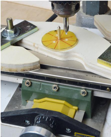
Mit einem Zentrierbohrer werden zuerst die Markierungen auf den im Winkel von 120 Grad aufgetragenen Strahlen eingebracht
