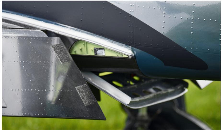
Welche Scale-Optionen sich mit der Trojan umsetzen lassen, zeigt dieses Beispiel mit Trittfläche, Nieten, Knotenblechen, Klappen, Wartungsschild und mehr
