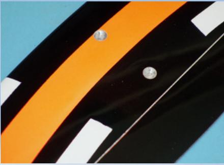
Die Farbübergänge sind sehr exakt ausgeführt. Das Höhenleitwerk glänzt mit Alu-Einsätzen im Bereich der Befestigungsschrauben
