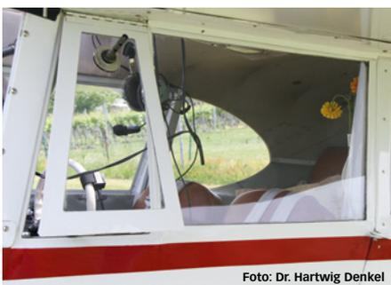
Als Schlechtwetter-Fenster und zur Lüftung kann ein Teil des vorderen linken Fensters aufgeklappt werden
