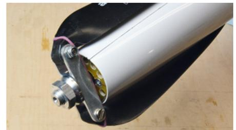
Für den Vortrieb sorgt ein 14 x 8-Zoll-Propeller
