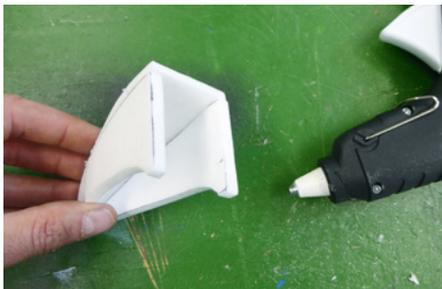
Die Motorgondel besteht aus drei Depronteilen und dem Motorspant aus Sperrholz. Zum kraftschlüssigen Verkleben von Depron und Holz eignet sich auch Heißkleber
