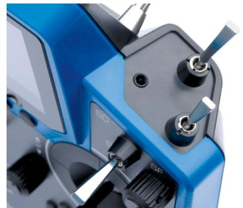
Rechts sind zwei normale, ein Tastschalter, ein weiterer Geber sowie der PPM-Anschluss platziert
