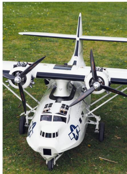
**Zu den Highlights gehörte die Catalina PB5A von Rainer Jörg, die mit ihren 4.000 mm Spannweite und den beiden synchronisierten Saito-Sternmotoren auf etwa 29 kg Abfluggewicht kommt**
