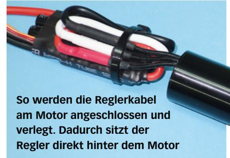
So werden die Reglerkabel am Motor angeschlossen und verlegt. Dadurch sitzt der Regler direkt hinter dem Motor
