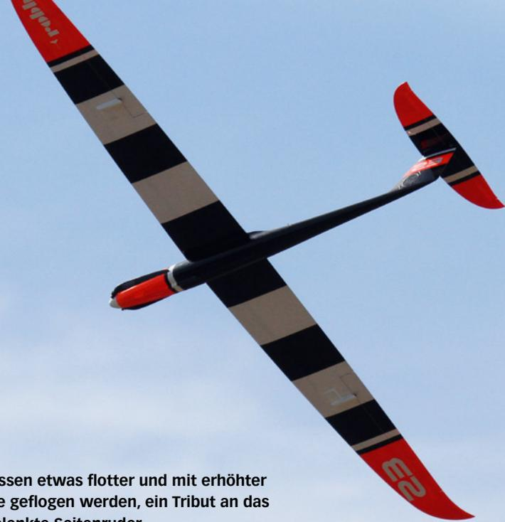
Kreise müssen etwas flotter und mit erhöhter Schräglage geflogen werden, ein Tribut an das nicht angelenkte Seitenruder
