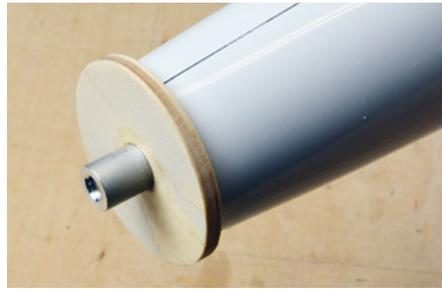
Mit dieser einfachen Vorrichtung wird der rechtwinklige Wellenaustritt eingestellt
