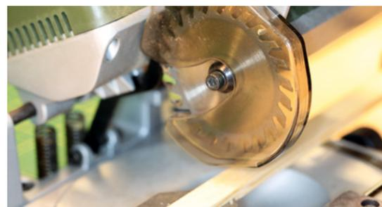
Kurz bevor das Sägeblatt die Leiste erreicht, fährt der Sägerblattschutz zurück – Sicherheit ist Trumpf
