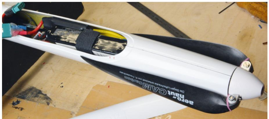
Verzichtet man auf die „Klappgummis“, kann der Spinner noch dichter an den Rumpf herangezogen werden
