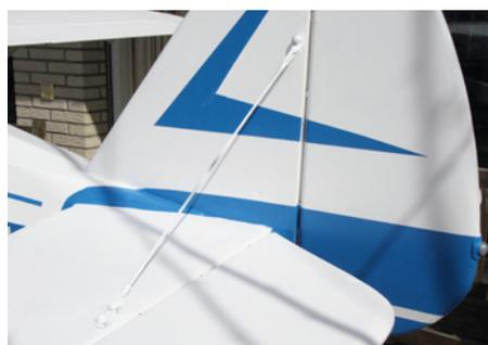
Bei der Tri Pacer blieb das Piper Cub-typische, abgestrebte Leitwerk erhalten. Auch hier beim Modell ist das sehr detailliert umgesetzt
