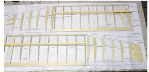
**Die Innenflügel sind fast fertiggebaut. Die Teile für die Außenflügel liegen auf dem Plan bereits parat**
