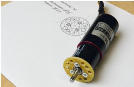
Die 80 mm lange Motor-Getriebeeinheit mit verschraubtem Motorspant
