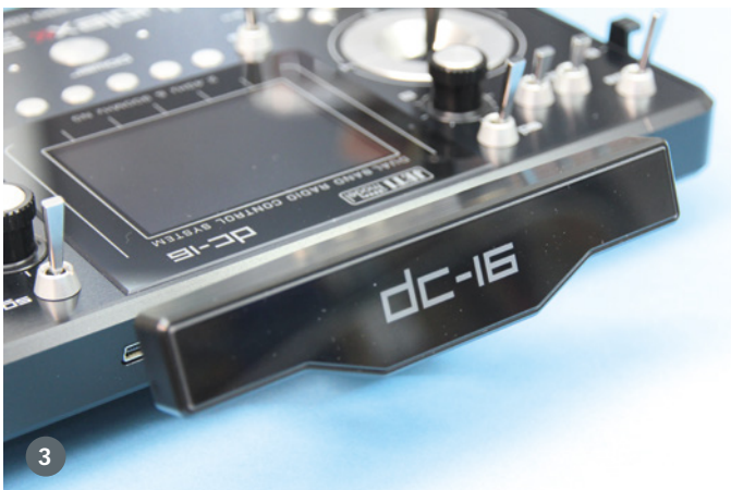
1. Die beiden seitlichen Schieber sind vielseitig verwendbar und haben eine deutliche Mittenrastung. 2. Die Trimmastasten seitlich unterhalb des Kreuzknüppels sind anfangs etwas gewöhnungsbedürftig, aber nach ein paar Flügen hat man den Bogen raus. 3. Im Antennenhalter sind insgesamt vier Antennen für das 2,4-GHz-Band und die 900-MHz-Antenne für das Backup-System untergebracht. 4. Bedient und programmiert wird der Sender unter anderem über die fünf runden Tasten unterhalb des Displays. Dort sind jeweils kontextbezogene Funktionen hinterlegt
