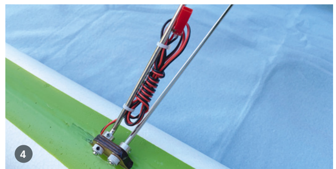
1. Der linke Schwimmer verfügt über ein wasserdicht eingebautes Servo zur Ansteuerung des Wasserruders. 2. Die Befestigung der Stahldrähte am Fahrwerksbrett erfolgt durch gefräste Metallteile. Diese werden an die vorhandenen Gewinde-Bohrungen geschraubt. 3. Im Lieferumfang finden wir auch Abdeck-Kappen, die die Kühlluft-Öffnungen gegen eindringendes Spritzwasser schützen. 4. Die Befestigung der Stahldrähte an den Schwimmern erfolgt über Stellringe an einem Sperrholz-Spant. Beide Schwimmer verfügen über eine integrierte Beleuchtung, die hier nicht zum Einsatz kommt, weshalb das Kabel fixiert ist
