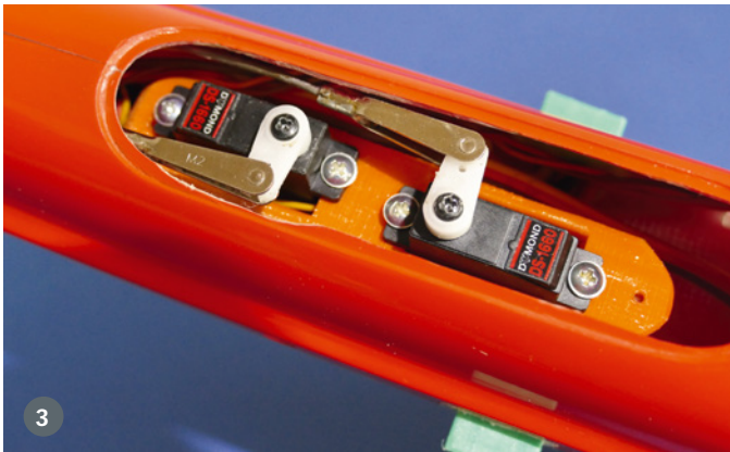
1. Bei Verwendung eines Standard-3s-LiPos ist perfekt Platz vorhanden und der Schwerpunkt lässt sich durch Verschieben einstellen. 2. Der mit einem 3D-Drucker selbst erstellte Empfänger- und Servoeinschub erleichtert den Einbau dieser Komponenten. 3. Eine gute Lösung ist die Service-Luke an der Rumpfunterseite für Empfänger- und Servoeinbau. 4. Multilock und Multiplex-Steckverbindungen sowie Torsionsstifte an der Wurzelrippe
