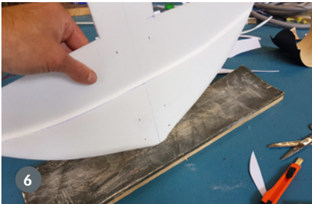
5. Die Rumpfseitenwände werden einfach auf die Flügelunterseite geklebt. 6. Jeweils etwa 1 Grad Seitenzug und 1 Grad Motorsturz werden am Rumpfbug vor Montage des Motorspantz zurecht geschliffen. 7. Uhu Por eignet sich sehr gut für Ruderscharniere. Hierzu auf beide Kanten auftragen, ablüften lassen und dann alles exakt zusammenfügen. 8. Die Seitenflosse wird an der Nasenleiste profiliert, an der Endleiste bleibt sie unbearbeitet
