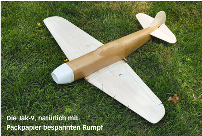
Bei der ersten Haube wurde PLA verwendet. Funktioniert und sieht gut aus, doch dann schlugen die sommerlichen Temperaturen zu. Leider wurde das PLA weich und die Haube verbeulte sich
