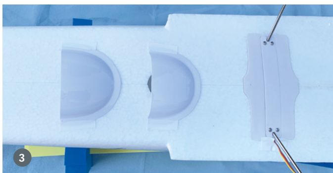
1. Der linke Schwimmer verfügt über ein wasserdicht eingebautes Servo zur Ansteuerung des Wasserruders. 2. Die Befestigung der Stahldrähte am Fahrwerksbrett erfolgt durch gefräste Metallteile. Diese werden an die vorhandenen Gewinde-Bohrungen geschraubt. 3. Im Lieferumfang finden wir auch Abdeck-Kappen, die die Kühlluft-Öffnungen gegen eindringendes Spritzwasser schützen. 4. Die Befestigung der Stahldrähte an den Schwimmern erfolgt über Stellringe an einem Sperrholz-Spant. Beide Schwimmer verfügen über eine integrierte Beleuchtung, die hier nicht zum Einsatz kommt, weshalb das Kabel fixiert ist
