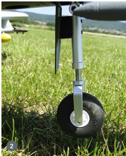
1. Die Elf-Blatt Impeller sind ein Phänomen. Im Flug sind sie kaum zu hören – plötzlich vermisst man das (!) – und die Leistungsentfaltung ist immer beeindruckend hoch. 2. Rasentauglich, das trifft auf das gefederte, außerordentlich robuste Einziehfahrwerk zu. 3. Die Anlenkung mit Kugelgelenken an allen Rudern ist vorbildlich gemacht und absolut spielfrei
