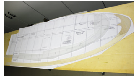
Beim Tragflächenbau wurde zuerst die Flügelendleiste hergestellt. Das Baubrett war angesichts der 490 mm Flächentiefe gerade so ausreichend
