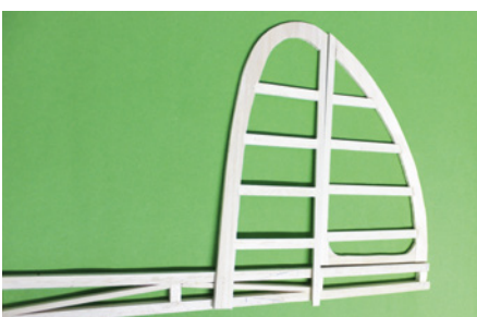
Das Seitenleitwerk geht durch den Rumpf durch. Das Ruder ist gegenüber dem ursprünglichen vergrößert worden
