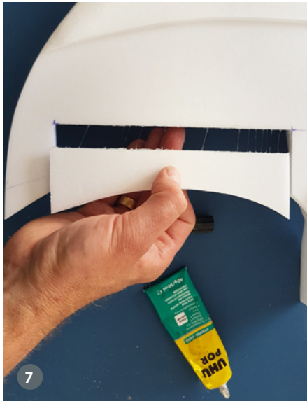
5. Die Rumpfseitenwände werden einfach auf die Flügelunterseite geklebt. 6. Jeweils etwa 1 Grad Seitenzug und 1 Grad Motorsturz werden am Rumpfbug vor Montage des Motorspantz zurecht geschliffen. 7. Uhu Por eignet sich sehr gut für Ruderscharniere. Hierzu auf beide Kanten auftragen, ablüften lassen und dann alles exakt zusammenfügen. 8. Die Seitenflosse wird an der Nasenleiste profiliert, an der Endleiste bleibt sie unbearbeitet
