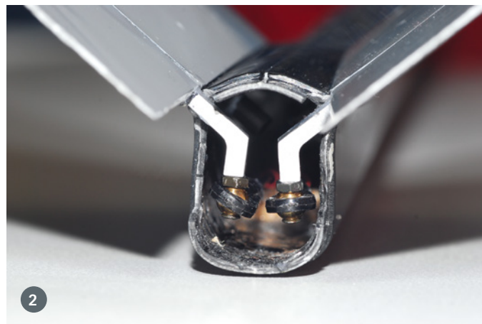
1. Mit Uhu plus endfest 300 lassen sich die perfekt sitzenden Steckungen dauerhaft fixieren. 2. Um einen größeren Anlenkungshebel zu erreichen, wurden die Kugelköpfe um eine Mutternlänge nachträglich etwas verlängert
