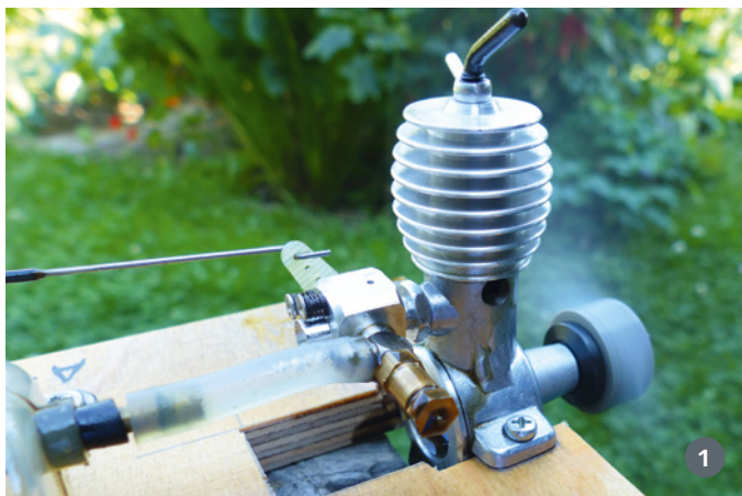
1. Der 040 PB mit 0,6 cm 3 hier mit zusätzlich angebauter Drosselvorrichtung wird von PAF vertrieben und konnte auch am Prüfstand überzeugen. 2. Der Super Atom, ein Langhuber von PAF, mit seinen 1,8 cm 3 ist in der Lage, 10 × 4-Zoll-Props zu drehen, die üblicherweise auf einem 4,5-cm 3 -Verbrenner geschraubt werden
