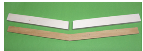
Die Flächensteckung aus Holz lagert in Sperrholz-Kästen. Der Winkel ist mit 15 Grad üppig
