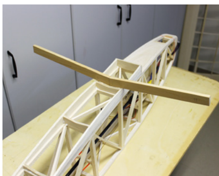
Der Flügel sitzt auf einem kleinen Pylon und wird klassisch mit Gummis befestigt. Hier kann man auch gleich die EWD einstellen
