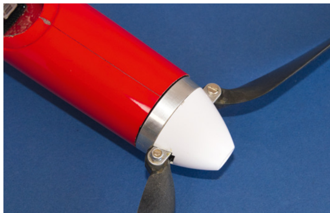
Der Präzisionsspinner schafft einen sauberen Übergang zum Rumpf
