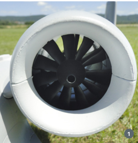
1. Die Elf-Blatt Impeller sind ein Phänomen. Im Flug sind sie kaum zu hören – plötzlich vermisst man das (!) – und die Leistungsentfaltung ist immer beeindruckend hoch. 2. Rasentauglich, das trifft auf das gefederte, außerordentlich robuste Einziehfahrwerk zu. 3. Die Anlenkung mit Kugelgelenken an allen Rudern ist vorbildlich gemacht und absolut spielfrei
