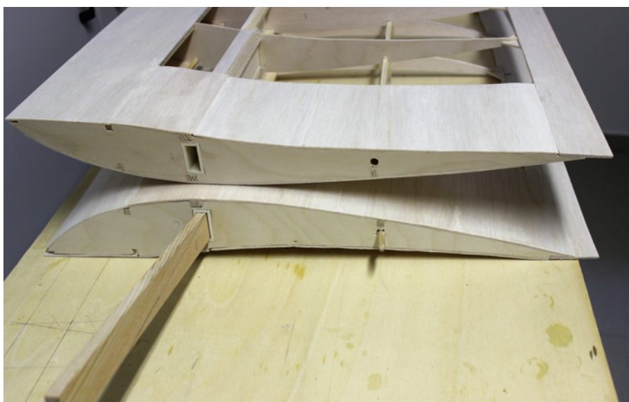
Hier sieht man schön das Thermikprofil und die Steckung. Die im Querschnitt erkennbaren Hilfsholme haben beim Beplanken geholfen
