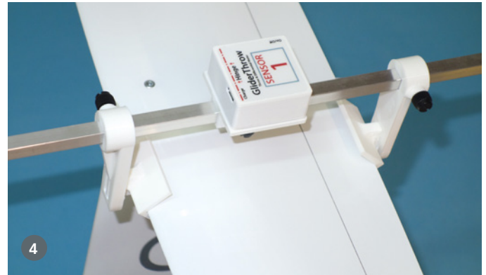
3. Hier wird die EWD an der Ikura von aer-o-tec vermessen. Nachdem beide Sensoren am Höhenleitwerks-Support angebracht und genullt wurden, wird der Sensor 2 nach vorne auf den Flächen-Support gesetzt. 4. Durch die verstellbaren Support-Auflagen sind auch kleine Flächentiefen kein Problem
