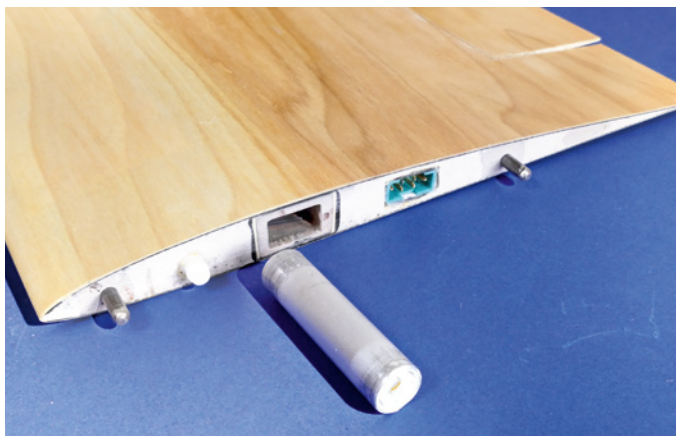
Die Multilock-Verbindung sorgt für eine sichere Befestigung der Flächen
