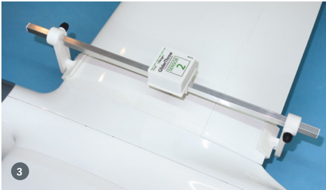
3. Hier wird die EWD an der Ikura von aer-o-tec vermessen. Nachdem beide Sensoren am Höhenleitwerks-Support angebracht und genullt wurden, wird der Sensor 2 nach vorne auf den Flächen-Support gesetzt. 4. Durch die verstellbaren Support-Auflagen sind auch kleine Flächentiefen kein Problem
