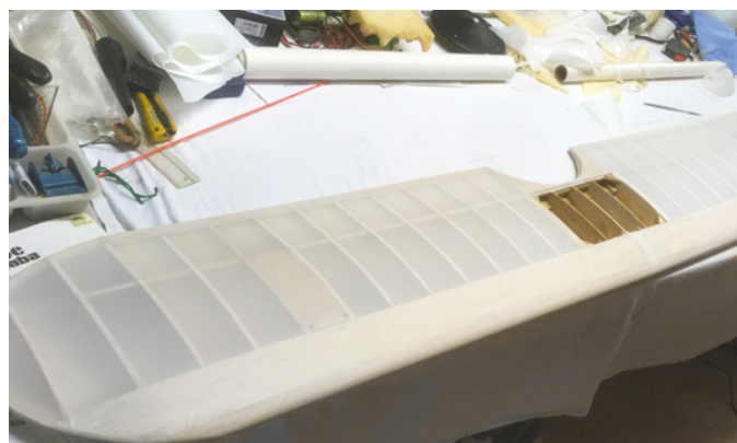
Der Oberflügel ist bis auf die zentrale Wartungsklappe, um gut an die Baldachin-Schrauben heranzukommen, fertig
