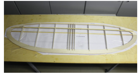
Das gut 1.200 mm spannende Höhenleitwerk nimmt langsam Formen an. Basis für den Bau des gesamten Modells waren die vergrößerten Bauplankopien
