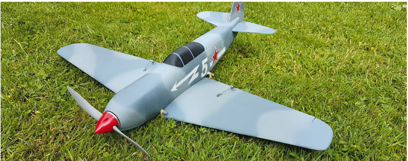
Eine zweite Haube wurde aus PETG gedruckt, das wesentlich temperaturstabiler ist. Jetzt ist die Haube auch sommertauglich und die Jak-9 ist bereit für die WM 2021
