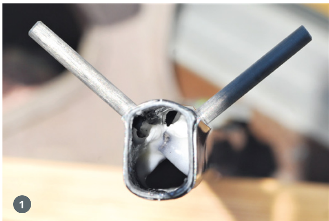
1. Mit Uhu plus endfest 300 lassen sich die perfekt sitzenden Steckungen dauerhaft fixieren. 2. Um einen größeren Anlenkungshebel zu erreichen, wurden die Kugelköpfe um eine Mutternlänge nachträglich etwas verlängert
