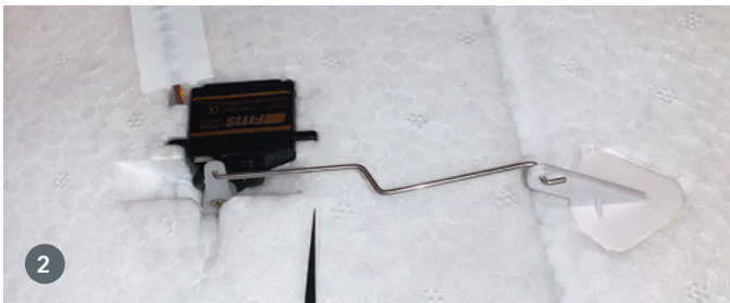
1. Weit vormontiert kommt die FMS Edge 540 von D-Power aus der Verpackung. Motor, Regler sowie Servos sind herstellerseitig installiert und der Reflex-Kreisel liegt lose bei. 2. Eines der beiden Querruderservos. Alles ist flugfertig angelenkt und aufgrund der Z-förmig vorgebogenen Gestänge lässt sich die Nullstellung durch Nachbiegen anpassen. 3. Die Spinnerkappe aus EPO läuft absolut rund und erzeugt keine Unwucht. Motor, Propeller und Spinner sind betriebsbereit montiert. 4. Bei der Anlenkung von Seiten- und Höhenruder kommen in Z-Form gebogene Gestänge zum Einsatz. Das Spornrad ist am Seitenruder befestigt und dadurch lenkbar
