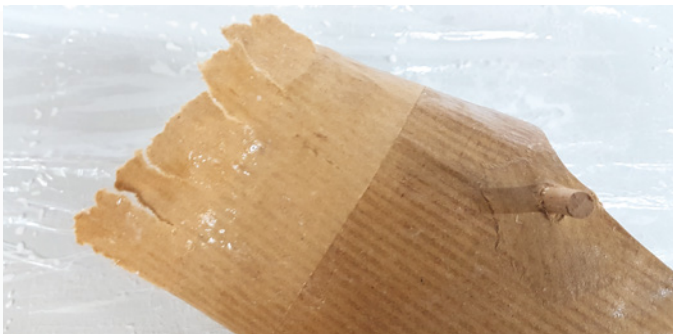
Abschluss am Motorspant: Die breiten Streifen werden immer ungefähr 1 mm länger zum Rumpf in kleinen Einzelstreifen an und um die Kante gelegt
