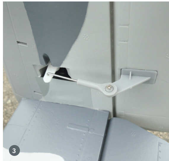
1. Die Elf-Blatt Impeller sind ein Phänomen. Im Flug sind sie kaum zu hören – plötzlich vermisst man das (!) – und die Leistungsentfaltung ist immer beeindruckend hoch. 2. Rasentauglich, das trifft auf das gefederte, außerordentlich robuste Einziehfahrwerk zu. 3. Die Anlenkung mit Kugelgelenken an allen Rudern ist vorbildlich gemacht und absolut spielfrei
