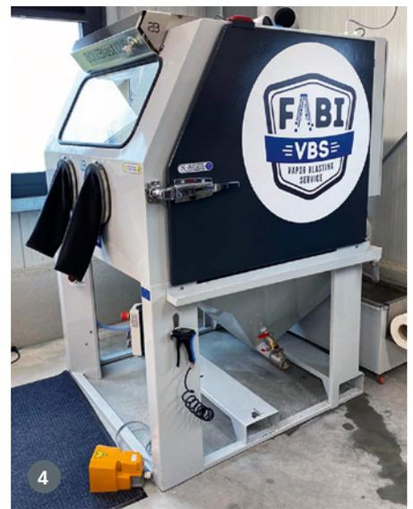
3) Zwischen die einzelnen Kühlrippen haben sich Rückstände von Öl, Staub und Fasern gesetzt und alles so stark verklebt, das klassische Reinigungsmethoden versagen. 4) Die Firma Fabi-VBS bietet als besonderen Service das Abstrahlen von Metallteilen im Vapor-Blasting-Verfahren an, das in dieser Maschine stattfindet
