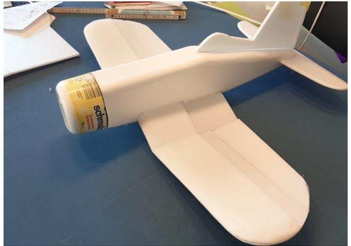
Ein leichter, stabiler Plastikbecher im passenden Durchmesser dient als Motorhaube
