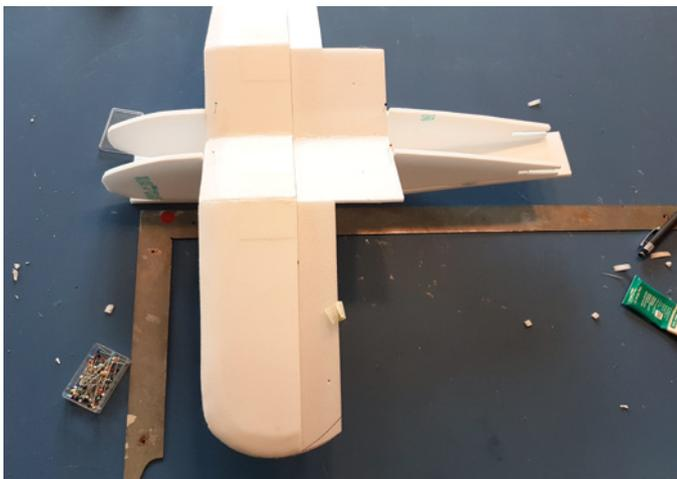
Alle Winkel sind mit Augenmaß und, wenn vorhanden, Hilfsmitteln zu überprüfen – Stecknadeln fixieren den Flügel. Glasfasertape stabilisiert den Knick
