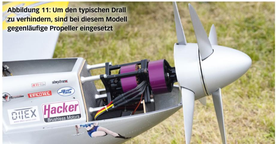
Abbildung 11: Um den typischen Drall zu verhindern, sind bei diesem Modell gegenläufige Propeller eingesetzt
