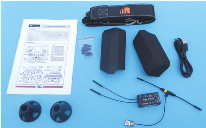
Außer dem voll ausgebauten Sender gehören eine Kurzanleitung, ein Trageriemen, ein USB-Kabel, Schalterkappen sowie ein 2,4-GHz- und ein 868-MHz-Empfänger zum Lieferumfang des Bundles
