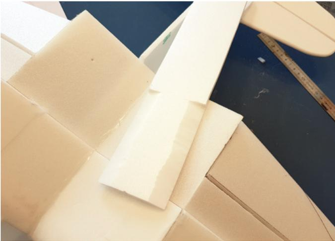
Der hintere Rumpfrücken muss im Flügelbereich dem Flügelknick angepasst werden
