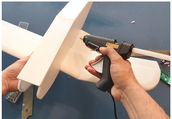
Eine Methode zum Befestigen des Knickflügels ist Heißkleber
