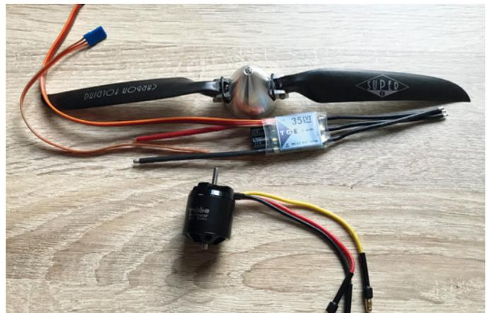
Das Antriebssetup besteht aus einem 72 g schweren Brushless-Motor, einem 35-A-Regler und einer 11 x 6-Zoll-Klappflugschraube
