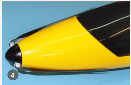
4) Der Spinner-Rumpf-Übergang mit Hilfe des 44-mm-Scale-Spinners von Reisenauer ist gut gelungen
