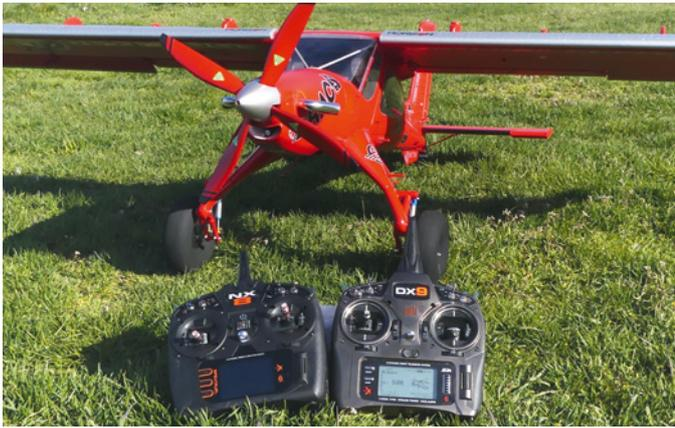
Für den Test standen zwei Anlagen zur Verfügung, eine recht neue Spektrum NX8 des Verlags und die eigene Spektrum DX9 des Autors. Beide Sender können die vom eingebauten Empfänger zur Verfügung gestellten Telemetrie-Daten empfangen und anzeigen
