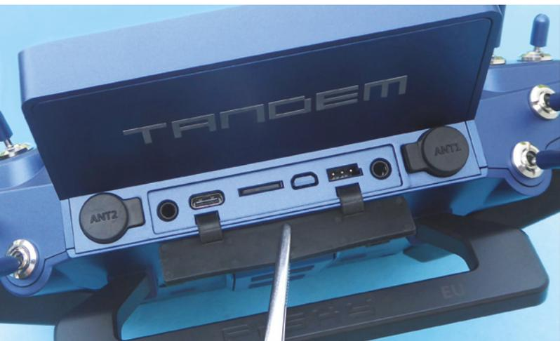
**Sämtliche Ports einschließlich eines Micro-SD-Karten-Slots sind, durch eine Abdeckung geschützt, gut zugänglich**
