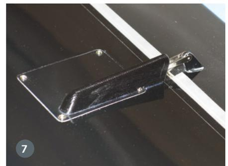
5) Gestängehutzen aus dem 3D-Drucker waren bei uns das Mittel der Wahl. Alternativ können auch die Hutzen aus den mitgelieferten ABS-Teilen ausgeschnitten und schwarz lackiert werden. 6) Aufgeklebt werden die Hutzen mit Silikon. Über Nacht mit Gewichten beschwert, hält dies über Jahre und ist bei Bedarf trotzdem abnehmbar. 7) Hier die Abdeckung im fertigen Zustand
