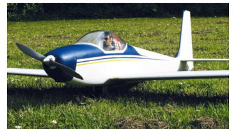
Abbildung 4: Diese ASK-14 hat knapp 600 W Startleistung, im Reiseflug geht es jedoch auf knapp 70 W zurück – bei einem Verstellpropeller könnten es auch weniger als 40 W sein
