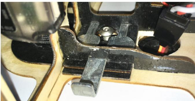
Gute Lösung: Die Tragflächen werden über Metall-Schiebeelemente verriegelt. So benötigt man zum Aufbau des Modells keinerlei Werkzeug
