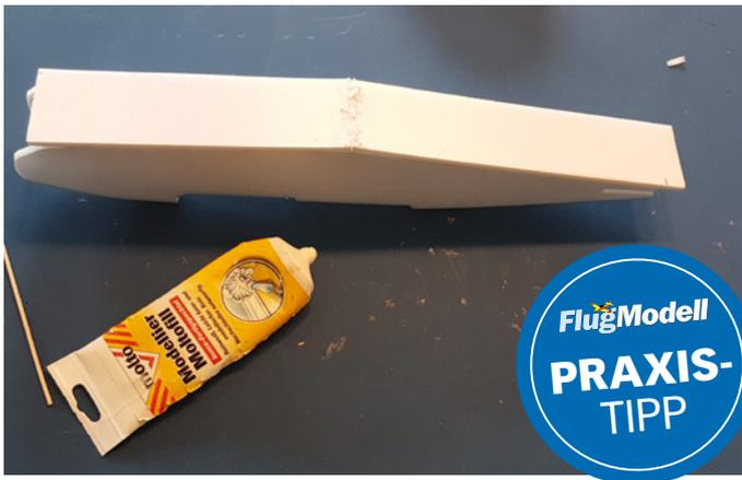
Ideal zum Füllen von Spalten bei Depron-Modellen ist Modeller Moltofill. Ausgetrocknet ist es sehr leicht und gut zu schleifen
