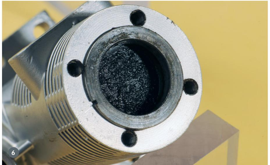
5) Ergebnis der Reinigung aus Vapor-Blasting und Reinigen an Zylinderkopf mit eingesetzter Zündkerze. 6) Vor dem Einweichen beziehungsweise Reinigen ist erkennbar, dass der Kolben dick mit schwarzer Ölkohle verkrustet ist
