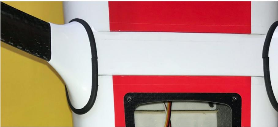
Das profilierte CFK-Fahrwerk wird mit drei M4-Schrauben an der soliden Rumpfstruktur befestigt. Das Formteil, das diesen Bereich passend zur Rumpfkontur verkleidet, wurde ergänzend aus Balsa hergestellt
