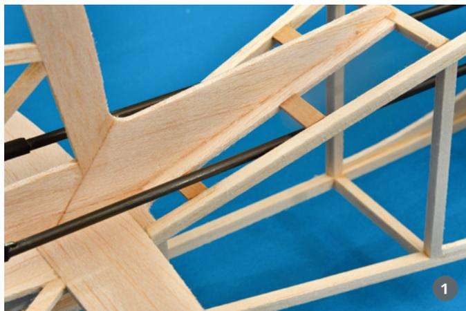
1) Der Rumpf von DoppelHOPPER besteht aus einer leichten Balsa-Gitterkonstruktion. Im Gegensatz zu seinem Vorfahren HOPPER wird später aber alles komplett mit Folie bespannt. Deshalb sind die Durchführungsstellen der Schubstangen mit Querstäbchen begrenzt, damit dort die Folie aufliegen kann
