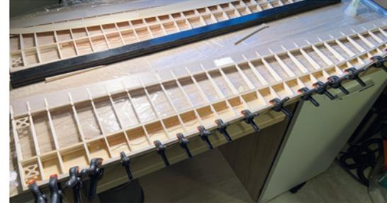
Auf einem ebenen Baubrett entstehen parallel die beiden Flächenhälften – hier werden Nasenleiste und Beplankungsbretchen miteinander verklebt
