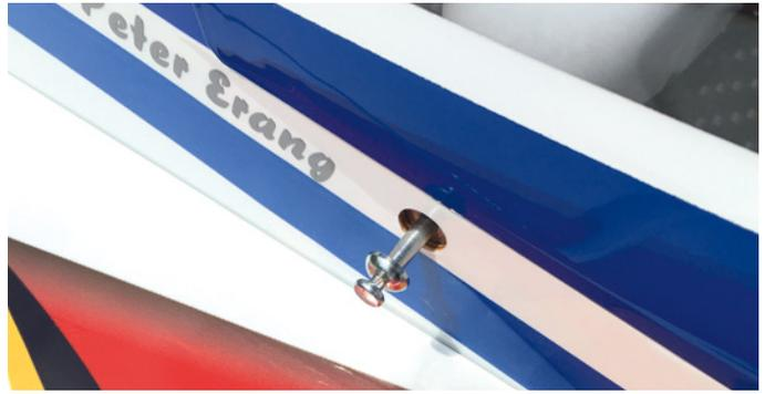
Ab dieser Position wird der Bolzen durch den Magnet in seine finale Position gezogen und ist dadurch verliersicher
