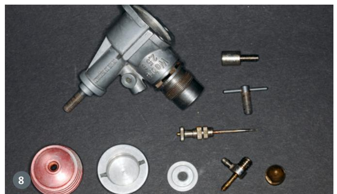
7) Anschließend wird er gut 30 Minuten in Meister Propper (1:1 mit Wasser verdünnt) versenkt – dann lässt er sich mühelos reinigen. 8) Gereinigte und konservierte Teile eines Motors, die bereit zur Montage und der erneuten Betriebsaufnahme sind
