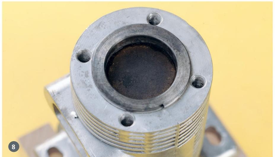
7) Im Gehäuse ‚schwimmt‘ der alte Ölsumpf und hat alles verklebt. Da dreht sich nichts mehr. 8) Nach dem Einweichen und Reinigen sind Kolben und Zylinderwandung sauber. Gereinigt wurde hier mit Harzlöser
