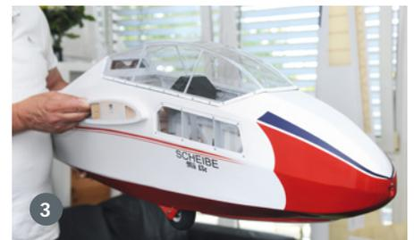
1) Aufgrund des Maßstabs 1:3,5 ließe sich auch ein gut ausgebautes Cockpit realisieren. 2) Über Seil angelenktes Seitenruder. Das Höhenruder ist zum Transport demontierbar. 3) Rumpf mit Kabinenhaube – die seitliche Verglasung gab's beim Original in der Export-Version
