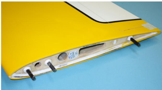
Im Wurzelbereich der Tragfläche finden sich sowohl die eingeklebten Torsionsstifte als auch ein Gewindebolzen, um die Tragfläche per Rändelschraube am Rumpf zu fixieren
