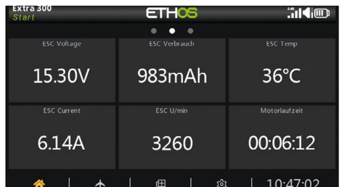
Über einen FrSky Neutron-Regler und die Empfänger-Sensorik werden alle relevanten Telemetrie-Daten im Modell erfasst und dann zum Beispiel so im Display angezeigt
