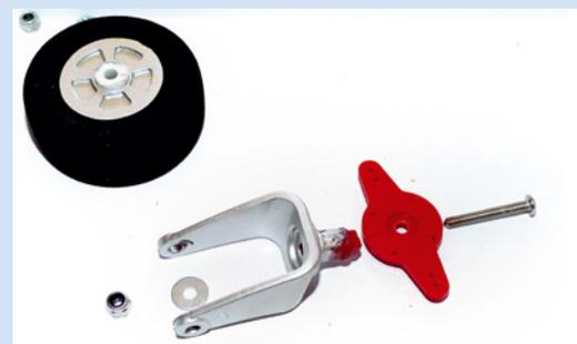
In wenigen Minuten konnte der Schaden mit einer auf 3 mm aufgebohrten Lagerung, einer passend abgelängten 3-mm-Schraube, einer Unterlagscheibe und einer Stoppmutter dauerhaft repariert werden. Die Bruchstelle selbst wurde zuvor mit Sekundenkleber fixiert. Optimiert man das gleich bei der Erstmontage des Modells, beugt man vor
