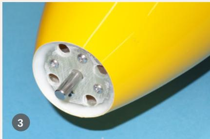
3) Eine satte Verklebung des Motorspant auf beiden Seiten ist extrem wichtig
