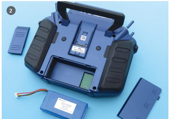
1) Wesentliche Angaben sind auf dem Display angeordnet – es ist auch bei Sonnenlicht gut ablesbar. 2) Im rückseitigen Akkufach ist ein 2s-LiPo platziert. Darüber ist der Schacht für ein externes HF-Modul untergebracht. Gut erkennbar sind die beiden rückseitigen Tasten
