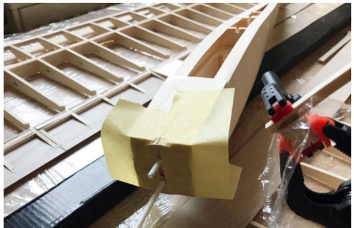
Ausrichten und Verkleben der Aufdoppelung des Motorspant
