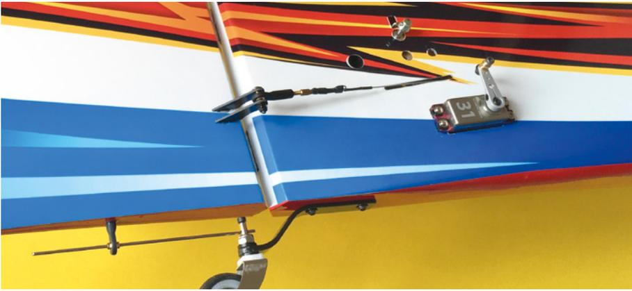
Das Heckfahrwerk besitzt einen CFK-Bügel, der mit zwei M3-Schrauben befestigt wird. Die beiden Höhenruderservos sitzen direkt im Rumpfheck, das Seitenruderservo hingegen vorne im Kabinenbereich
