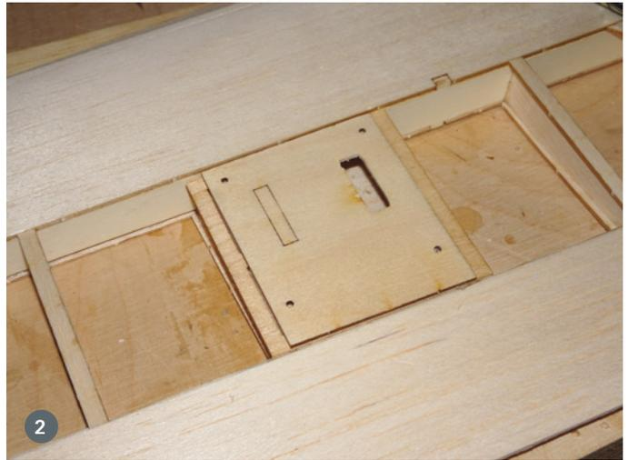
1) Bevor man die D-Box schließt, müssen unbedingt die Servokabel eingezogen werden. 2) Ganz wichtig, wenn man nur einen Sechskanal-Empfänger bauen will: Eines der Landeklappenservos muss um 180° gedreht eingebaut werden, damit beide über ein Y-Kabel am gleichen Kanal angeschlossen werden können.
