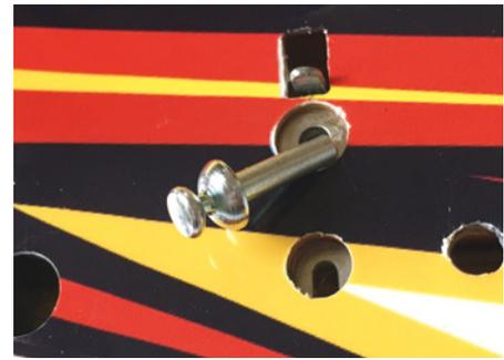
Wie bei den Flächen werden auch die beiden Höhenruderhälften mit einem Schieber verriegelt und durch den magnetischen Bolzen gesichert
