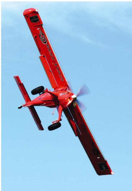
**Mit der Draco 2.0m kann auch hervorragend am Himmel geturnt werden. Erhält der Motor seine Power aus einem 6s-LiPo, hat er sogar genügend Leistung für Torquerollen und langgestreckten Messerflug. Durch das Hohlprofil der Flügel ist Rückenflug allerdings keine Stärke der Draco – hier benötigt sie eine Portion mehr Tiefenruder**
