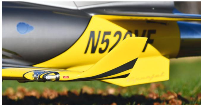
Kaum vorstellbar, aber Magnete von Hacker-Motor sichern die Winglets an den Flächen zuverlässig, sodass keine Schraubbefestigung nötig ist
