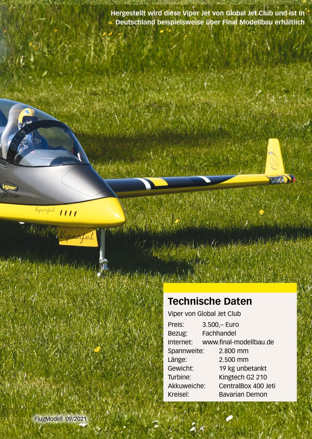
**D**ie Global Jet Viper wird bei uns durch Final Modellbau vertrieben. Es handelt sich um ein sehr leichtes, in Verbundbauweise hergestelltes Jetmodell. Eingebaut ist ein robustes, elektrisches Einziehfahrwerk von JP. Was fehlte, war die Turbine, doch dafür fand sich eine Lösung.
