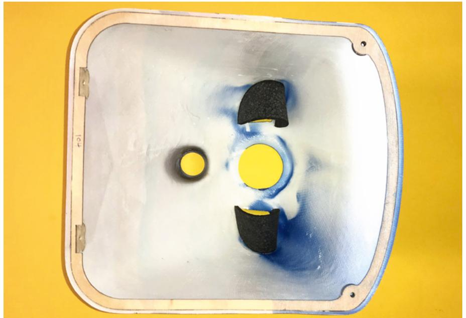
In der GFK-Motorhaube sind bereits herstellereitig Luftführungen zur Kühlung des E-Motors eingebaut
