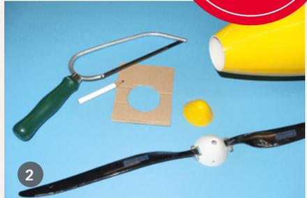
2) Mittels PUK-Säge und einer Pappschablone lässt sich die Rumpfspitze passend abtrennen
