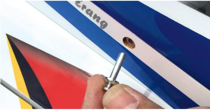
Nach Montage der Kabinenhaube – senkrecht aufsetzen und etwa 5 Millimeter nach hinten schieben – wird die Haube durch magnetische Bolzen verriegelt
