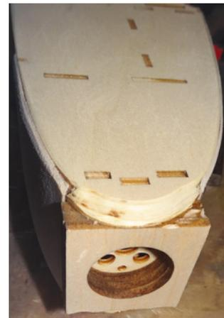
Vor dem Motorspant bilden drei dicke Holzscheiben die Verkleidung, die anschließend verschliffen werden muss
