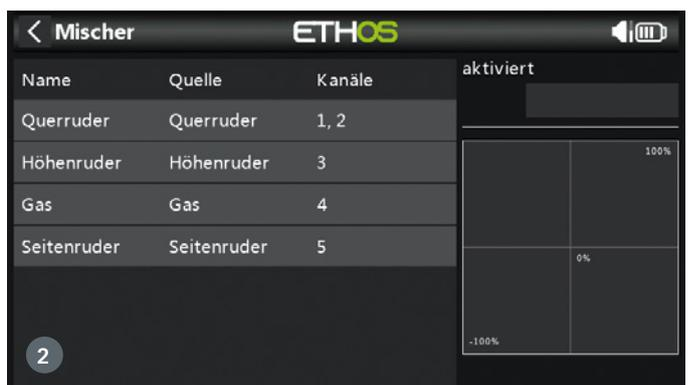
1) Im System-Menü, das sich über zwei Seiten erstreckt, lassen sich systematisch geordnet die modellübergreifenden Parameter konfigurieren. 2) ETHOS hat für die weitergehende Konfiguration Mischer eingerichtet und sinnvoll auf die Kanäle verteilt
