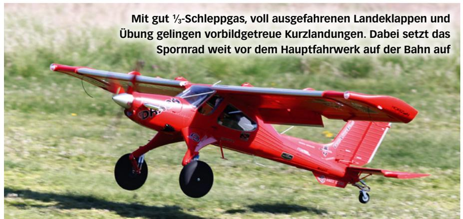
Mit gut  $\frac{1}{3}$ -Schleppgas, voll ausgefahrenen Landeklappen und Übung gelingen vorbildgetreue Kurzlandungen. Dabei setzt das Spornrad weit vor dem Hauptfahrwerk auf der Bahn auf
