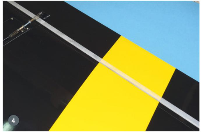
3) Zur Herstellung der einfachen Spaltabdeckung sind lediglich Klebeband, ein Skalpell und Baumwollflocken oder Talkumpuder notwendig. Das Klebeband wird halbseitig aufgebracht und am überstehenden Klebebereich mit Baumwollflocken bestrichen, um die Klebeschicht zu deaktivieren. 4) Nach dem Aufbringen sieht die Spaltabdeckung schon gefälliger aus
