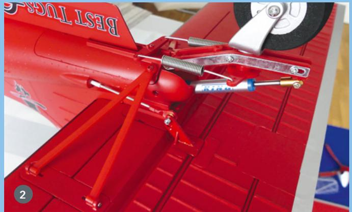
1) Im harten Einsatz besonders strapazierte Stellen des EPO-Modells sind mit intelligent gemachten Schutzkanten aus Hartplastik versehen. Das Foto zeigt den Scheuerschutz für die Fahrwerksverkleidung am Rumpf. Bei der Montage des Fahrwerks müssen die Verkleidungen unterhalb der Plastik-Lippe am Rumpf anliegen. 2) Das Höhenleitwerk kann bei Bedarf zum Transport/Lagern einfach demontiert werden
