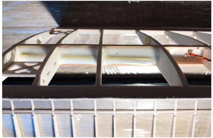
Satt mit Klebstoff befestigt ist die Flächensteckung, die aus einem Messingrohr besteht und zwischen den Holmleisten ruht
