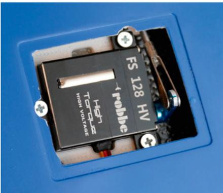
Der Einbau der Klappenservos erfolgt in Servorahmen. Für die Schraubbefestigung war der Ausschnitt anzupassen
