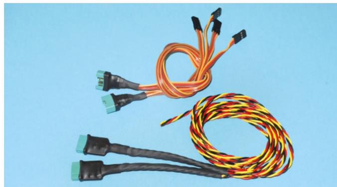
Der Kabelbaum ist recht schnell erstellt. Auf der Rumpfseite werden die Stecker verklebt und die Gegenstücke lose aus der Wurzelrippe herausgeführt
