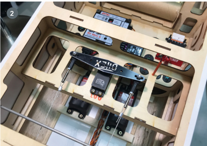
1) Der Spant direkt hinter der Kabinenhaube ist zur Verschraubung der beiliegenden Schleppkupplung bereits vorbereitet. Für eine gute Kräfteinleitung ist er doppelt nach hinten abgestützt. 2) Auf dem Seitenruderservo sitzt ein doppelter Hebel mit 100 mm Länge. Die Kugelgelenke sind unterhalb angebracht, damit die Stahllitzen nicht am nächsten Spant schleifen. 3) Der Rumpf ist von der Aufteilung her gut für den Einbau der Komponenten vorbereitet. Und man kommt jederzeit an alles gut heran. 4) Das Akkufach bietet genügend Raum für die Beleuchtungs- und Antriebsakkus. Letztere sitzen bei korrekter Schwerpunktlage so, dass sowohl nach vorne als auch nach hinten Platz für Korrekturen bleibt
