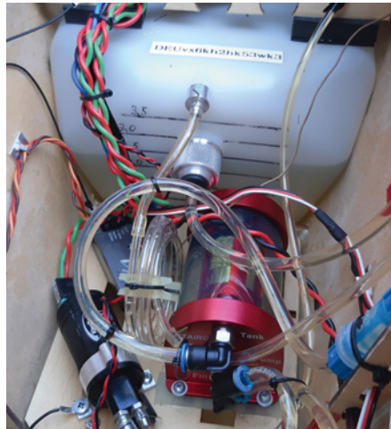
Spritpumpe, Hoppertank und Haupttank mit 3.500 ml Fassungsvermögen für ausgedehnt lange Flüge
