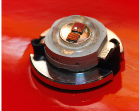
Das Beacon hat bereits seinen Platz auf dem Rumpfrücken eingenommen. Die transparente Abdeckkappe wird noch aufgeklebt
