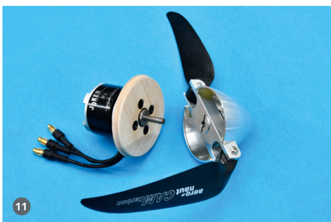
Der 58-g-Motor wird in Kopfspantmontage hinter seinem Pappelspertholz-Motorspant angeschraubt. Ein 40-mm-Alu-Spinner bildet die ideale Rumpfspitze, und aero-naut-Blätter sind stets eine gute Wahl
