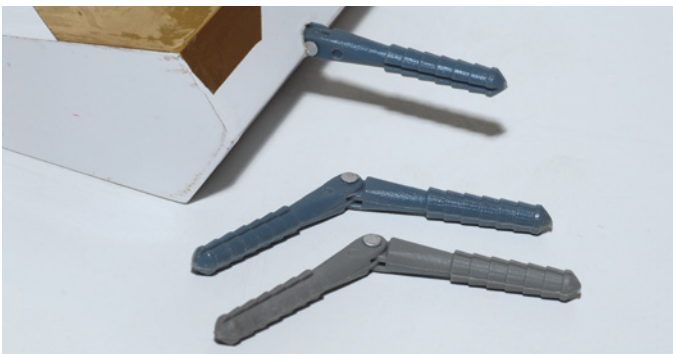
Sämtliche Ruderklappen sind mit soliden Stiftscharnieren anzuschlagen. Die Bohrungen dafür sind bereits angebracht
