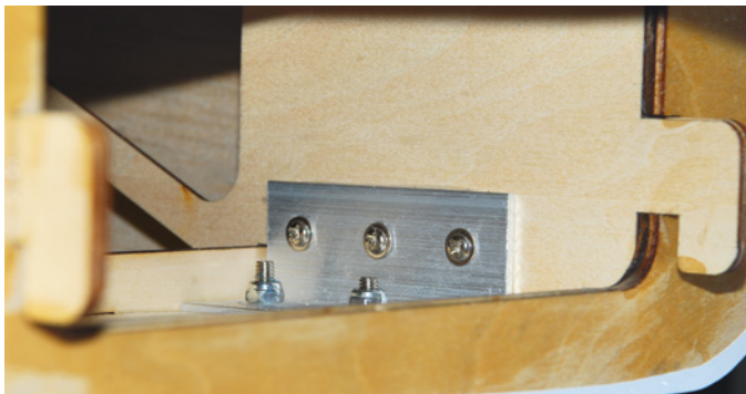
Ein bereits eingebauter, solider Alu-Winkel stellt den Kraftschluss zwischen Hauptfahrwerk und Rumpf sicher
