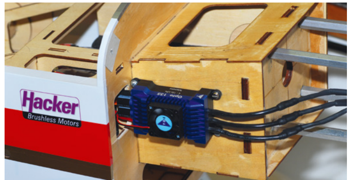
Der YGE Opto 135 stellt die optimale Ergänzung zum Hacker-Motor dar. So montiert bleibt die Verbindung zwischen Regler und Akkus kurz genug, um ohne Stützkondensatoren auszukommen
