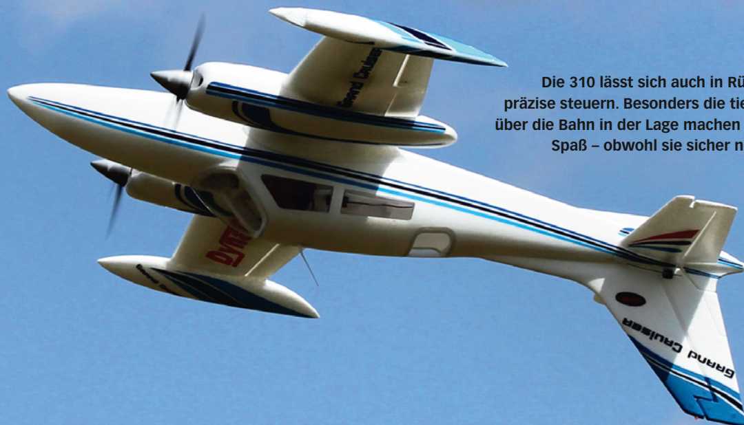
Höhen- und Seitenleitwerke können geschraubt oder/und auch geklebt werden. Im Testmodell wurden lediglich Schraubverbindungen eingesetzt
