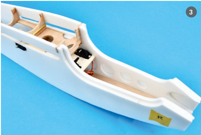
3 Der Rumpf besitzt im Bereich der Kabinenhaube eine Aufdopplung, wodurch die magnetisch gehaltene Depron-Haube ihren sicheren Sitz findet. Die Querruderservos schauen nach außen
