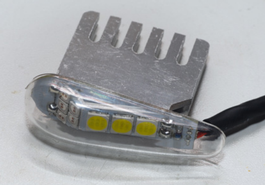
Zwei dieser Kombinationen von Blitzler und Positionslicht (rot und grün) werden in die Randbögen eingebaut
