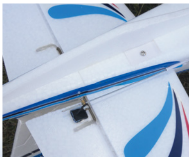
Die Höhenruder sind mit einem U-Stahl untereinander verbunden und werden von der linken Unterseite aus angelenkt
