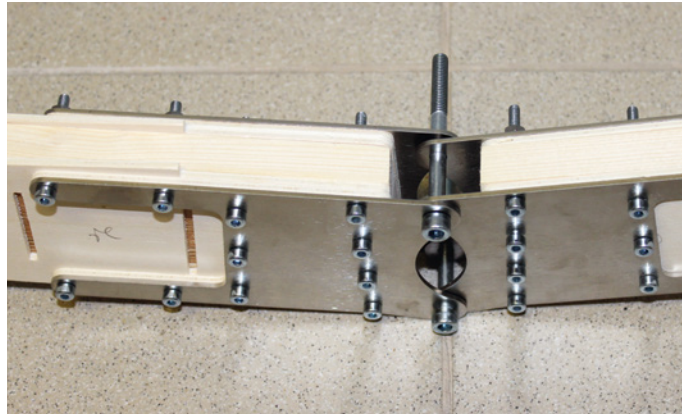
VA-Stahl als Beschläge sorgt für eine hochfeste Verbindung der Holme beziehungsweise Flächen
