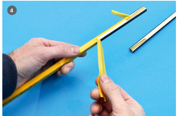
4 Als Klebstoff kommt beim Holm-Aufbau Pattex „Repair Extreme“ zum Einsatz. Der haftet irrsinnig, ist dauerelastisch-hart und alterungsbeständig. Zum Verpressen wurde alles über Nacht mit Klebeband fixiert
