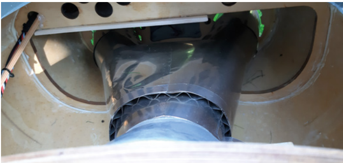
Ohne Hosenrohr geht es natürlich nicht – leider trägt es auch zu einer höheren Lärmemission bei
