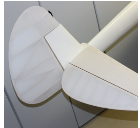
Die Bespannung erfolgt mit Oratex, da dieses Material den Eindruck von Seide gut widerspiegelt
