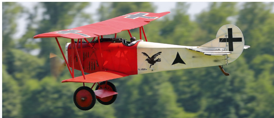
Der fantastische Nachbau der legendären Fokker D.VII von Frank Decker im Maßstab 1:3 mit 3.000 mm Spannweite und ZG 62 Benzinmotor mit Schlundt-Getriebe
