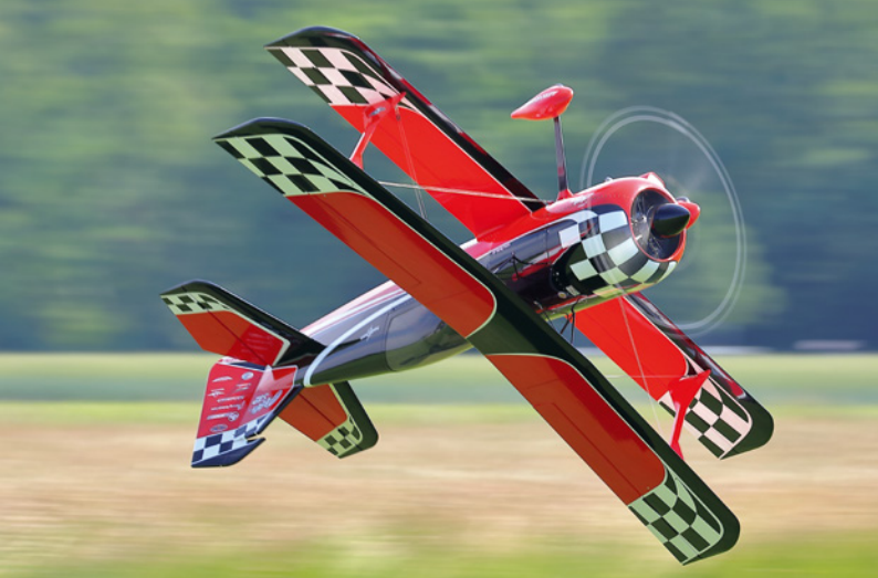
Jan Rottmann zeigte mit der Pitts S12 mit 2.700 mm Spannweite und Fünfzylinder-Sternmotor seine beeindruckende „Sternenkür“
