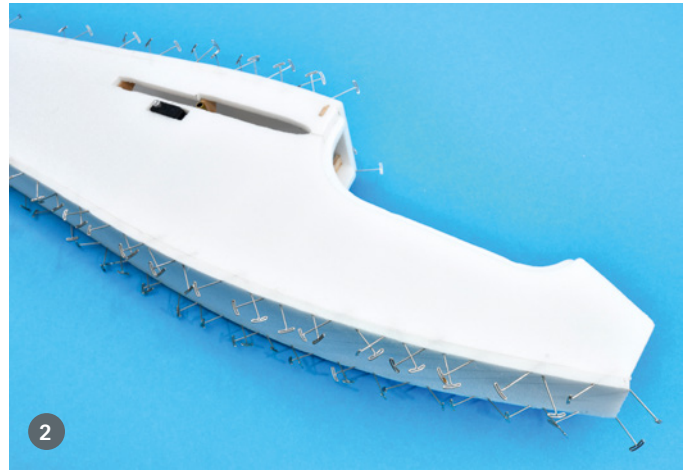
2 Bewährte Lieblingsmethode: Wasserfester Weißleim und 1.000 Stecknadeln, mindestens. Verzüge sind dadurch nahezu ausgeschlossen, und der Leim ist auf lange Sicht mechanisch stabil sowie UV-resistent
