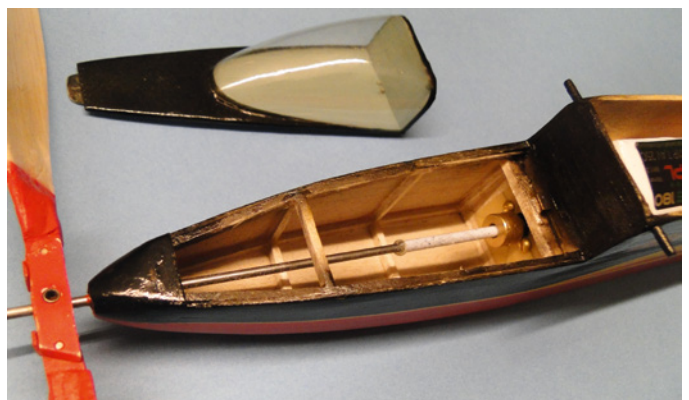
In der Rumpfnase überträgt die Stahldraht-Fernwelle die Motorkraft zum Propeller
