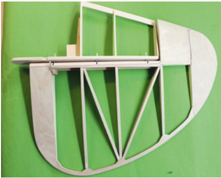
Weitgehend fertiggestelltes Seitenleitwerk mit angeschlagenem Seitenruder. Aufleimer geben dem Bespannmateriale später Fläche zum Anhaften
