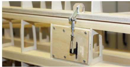
Das Querruderservo ist rückseitig auf den mit Schrauben gesicherten Deckel befestigt
