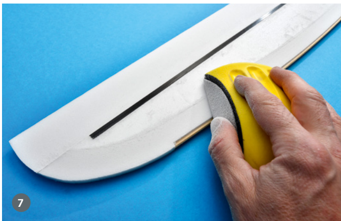
7 Der Nasenleistenbereich wird nach klaren Angaben im Bauplan erst in Schrägen verschliffen und dann weich verrundet. Auf diese Weise ist ein beidseitig identisches Ergebnis garantiert
