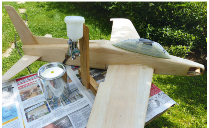
Die mit Japanpapier überzogene Holzkonstruktion vor dem Farbauftrag
