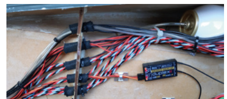
Praktisch sind die flammhemmenden Kabelschläuche, durch die sich sicher die Kabel führen lassen – hier scheuert nichts
