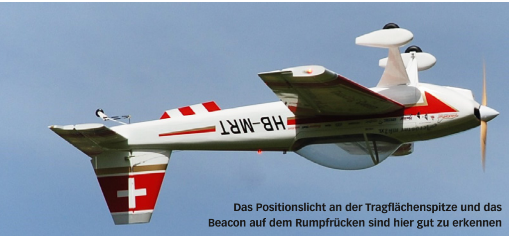
Zwei dieser Kombinationen von Blitzler und Positionslicht (rot und grün) werden in die Randbögen eingebaut
