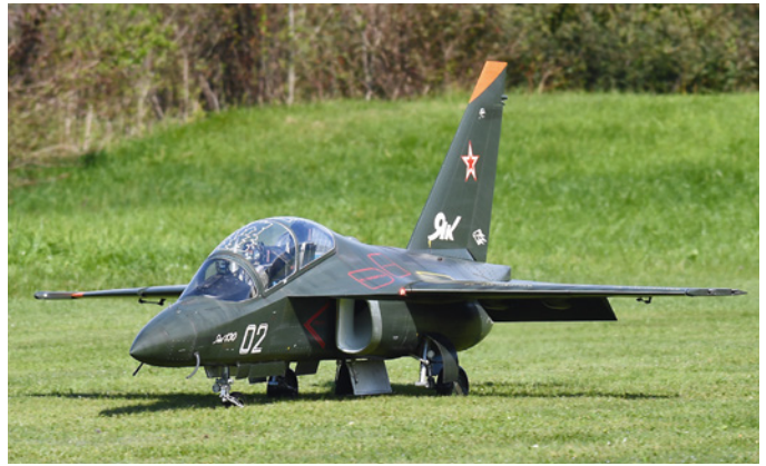
Schub liefert die verbaute Turbine Kingtech 180 reichlich, sodass Starts von der Graspiste gut möglich sind
