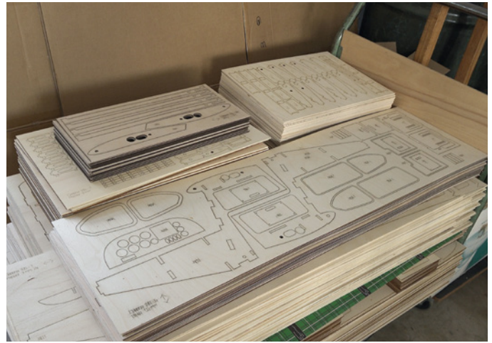
Bündelweise produzierte, frisch gelaserte Holzteile für eines der vielen Baukastenmodelle warten auf die Konfektionierung
