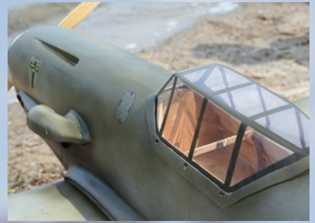
Gebaut nach Planvorlage aus Holz und bespannt mit Oracover-Folie hat der Eigenbau auch ein paar Details
