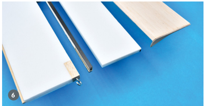
6 Der Flügel Aufbau in seinen Basis-Teilen: vorderer Bereich, dann der Holm, dann der hintere Bereich und ganz dahinter die Balsa-Querruder. Der Holm wird ebenfalls mit Pattex Repair Extreme dazwischen geklebt
