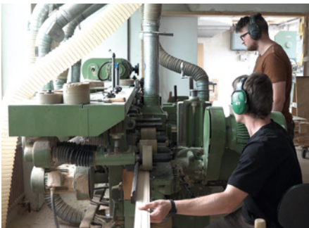
In der Holzwerkstatt kommen präzise, seit Jahren bewährte Industrie-Maschinen zum Einsatz, hier zum Profilieren von Leisten
