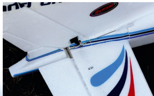
Damit die Seitenrudieranlenkung spannungsfrei läuft, wurde für die Lagerung des Bowdenzug-Röhrchens eine kleine, keilförmige Kerbe in die Nase der Höhen-Dämpfungsfläche geschnitten
