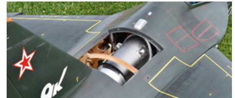
Direkt unter der Bremsklappe ist auch der Zugangsdeckel zur Turbine
