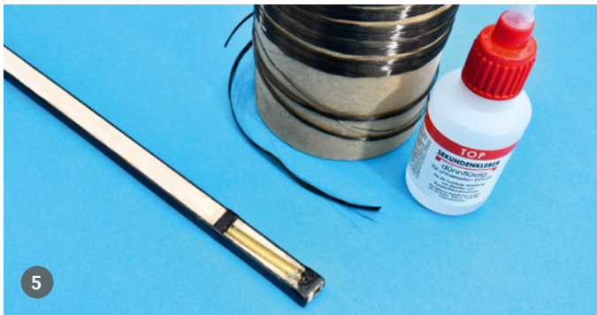
5 Damit der Holm bei der Flügelsteckung nicht aufspießt, sind ein paar Umwicklungen mit Kohleroving eine gute Lebensversicherung. Alternativ kann man auch Angelschnur oder Fesselfluglitze nehmen
