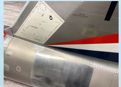
Bepunktungsbleche unterschiedlicher Materialien (Alu, Titan oder Carbon) sind scale dargestellt
