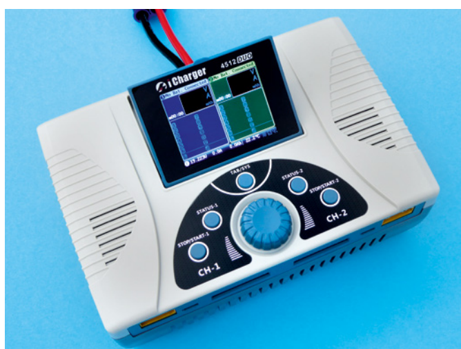
Das Ladegerät ist in einem zweiteiligen, stabilen Kunststoffgehäuse untergebracht, das viele Lüftungsschlitze aufweist
