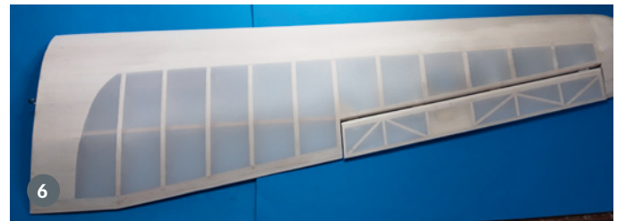
1) Klassische Bauweise der Dämpfungsflosse aus Vollbalsa, aber gesperrt, und der Ruder in Stäbchenbauweise. 2) Kunststoffscharniere sorgen für eine stabile, spielfreie Lagerung. 3) Senkrechte, flexibel einstellbare Montagewinkel helfen beim Bau des Kastenrumpfs. 4) Mit Balsaleisten lässt sich die Rundung des Rumpfrückens realisieren. 5) Nachträglich eingebrachte Erleichterungsbohrungen reduzieren das Rumpfgewicht um 60 g. 6) Ideal zum Bespannen und optisch einem Oldtimer nahekommend ist Proficover 2 von Practical Scale
