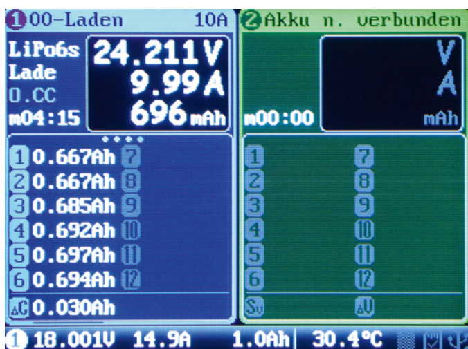
Beim Laden werden die wichtigsten Parameter übersichtlich visualisiert, beispielsweise Innenwiderstände aber auch (wie hier) die ge- oder entladene Kapazität der einzelnen Zellen
