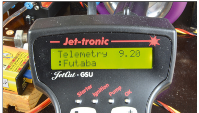
Für eine Telemetriennutzung sind zwei Einstellungen in der GSU notwendig
