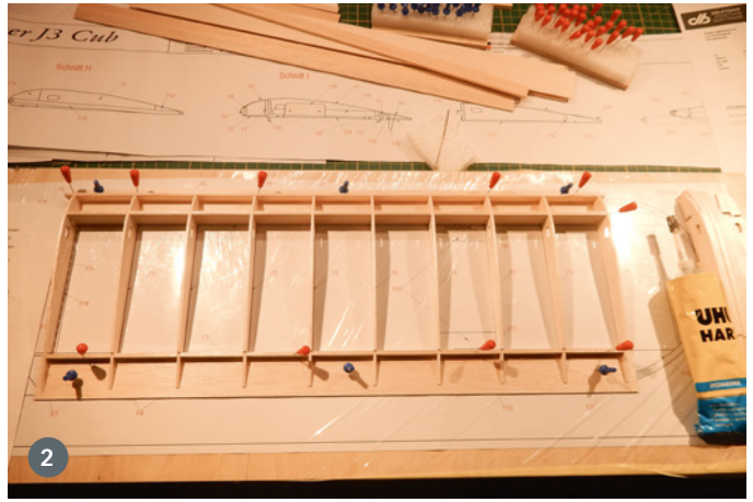
1) Das Fahrwerk wird mittels Glasfaser und Epoxidharz an seiner abnehmbar gestalteten Grundplatte befestigt und vor Ort weich gelötet. 2) Die Flügel entstehen klassisch auf dem Bauplan
