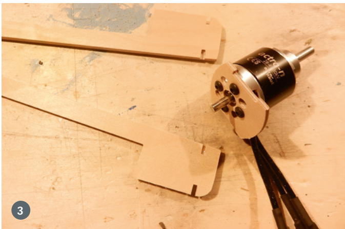
3) Das ist bemerkenswert: ein variabler Motorträger. 4) Das hat zum Vorteil, dass der Träger nur verschraubt und nicht verklebt werden muss, was das Ganze sehr flexibel macht
