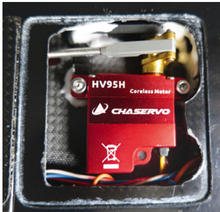
Vier Chaservos kommen ins Modell, die alle in stabilen Servorahmen sitzen
