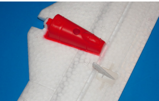
Mit einer Schraube lässt sich das Heck fixieren – anschließend ist das Anlenkgestänge einzuhängen
