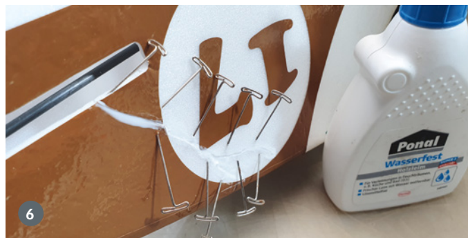
6) Zum Fixieren der Klebe- beziehungsweise Reparaturstelle sind Nadeln ideal
