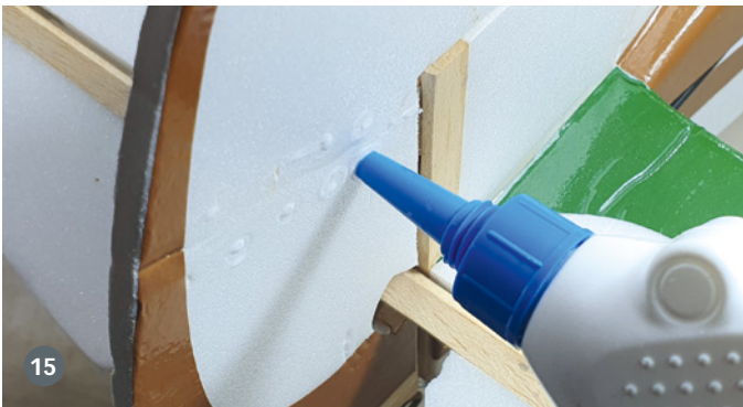
15) In die Einstichstellen presst man später Leim ein, das gibt zusätzlichen Halt
