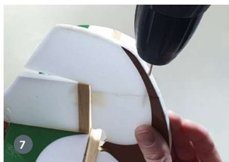
7) Eine unauffällige Verstärkung kann durch Einbringen eines Zahnstochers geschehen
