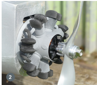
1) Das selbst gelötete Fahrwerk bedeutete zwar etwas Aufwand, passt aber gut zur Messerschmitt. 2) Aus dem 3D-Drucker eines Fliegerkameraden stammt die Mehrzylinder-Attrappe. 3) Damit der Akku sicher nicht verrutschen kann, fixiert ihn zusätzlich ein Winkel
