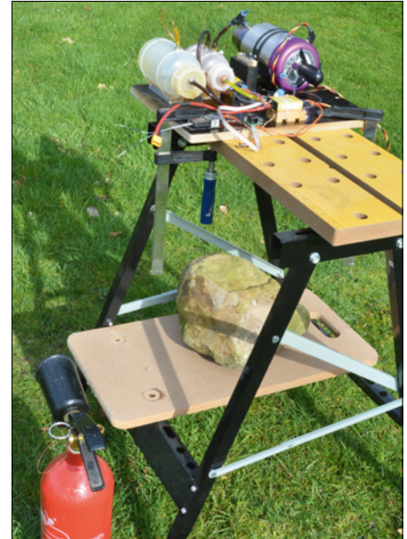
Der erste Lauf der Turbine findet auf dem Testbrett statt. Auch hier darf der Feuerlöscher nicht fehlen
