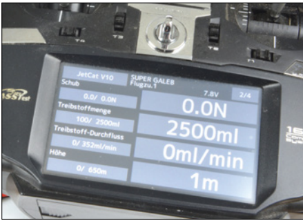
Ist die Telemetriefunktion aktiviert, stehen etliche Informationen auf dem Sender-Display zur Verfügung
