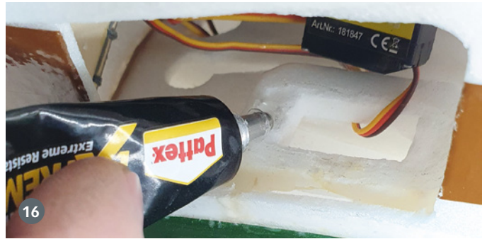
16) Ein neues Servo muss rein und da hilft Pattex Repair Extreme beim Befestigen
