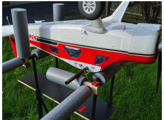
Senkrecht zum Fixieren und waagrecht als stützende Auflage
