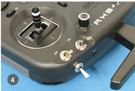
4) In der X14S sind hochwertige, kugelgelagerte Alu-Gimbal mit präzisen Hall-Sensoren eingebaut, die ein sehr gutes Feedback geben. 5) Beim Importeur Engel gehören eine deutschsprachige Kurzanleitung und USB-C-Ladekabel zum Lieferumfang. 6) Besonders am Twin-fähigen Empfänger GR6 ist die niedrige Latenzzeit, die ihn auch für sehr schnelle Modelle prädestiniert
