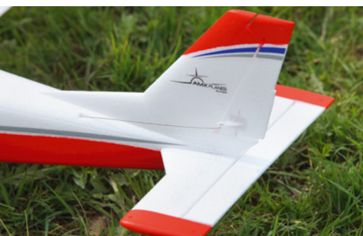
Ein etwas länger, aber einwandfrei funktionierender und spielfreier Anlenkdraht
