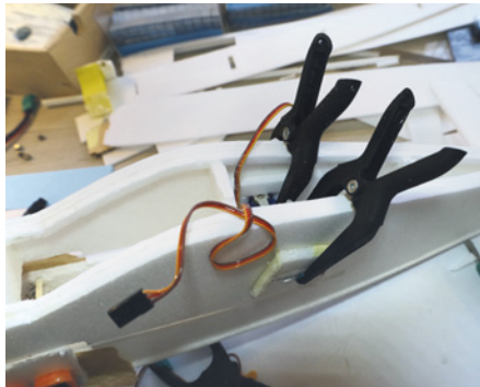
Servos sind innen einzukleben. Damit sie dabei nicht verrutschen, sichern sie Klammern
