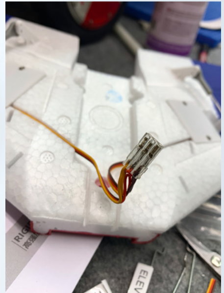
Fasst man Servokabel gezielt zusammen reduziert sich auch die Wahrscheinlichkeit, etwas falsch zu stecken
