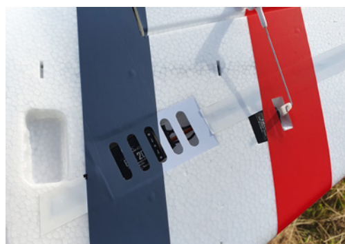
Servos und Regler sind ab Werk installiert – letztere zudem sehr gut gekühlt
