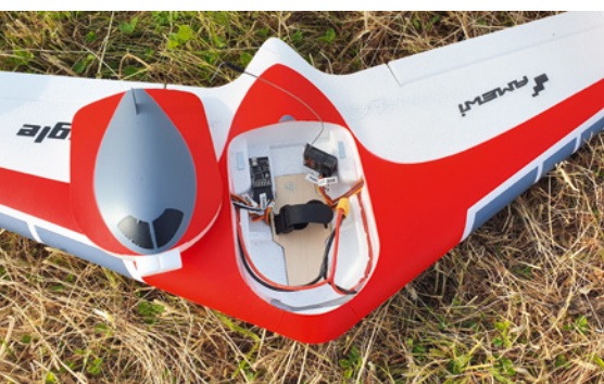
Die große Öffnung sorgt für einen Akkuwechsel ohne verkrampfte Finger
