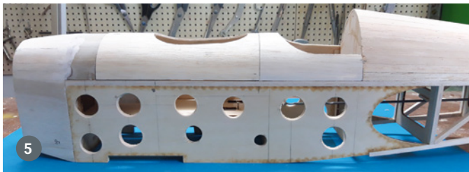
1) Klassische Bauweise der Dämpfungsflosse aus Vollbalsa, aber gesperrt, und der Ruder in Stäbchenbauweise. 2) Kunststoffscharniere sorgen für eine stabile, spielfreie Lagerung. 3) Senkrechte, flexibel einstellbare Montagewinkel helfen beim Bau des Kastenrumpfs. 4) Mit Balsaleisten lässt sich die Rundung des Rumpfrückens realisieren. 5) Nachträglich eingebrachte Erleichterungsbohrungen reduzieren das Rumpfgewicht um 60 g. 6) Ideal zum Bespannen und optisch einem Oldtimer nahekommend ist Proficover 2 von Practical Scale
