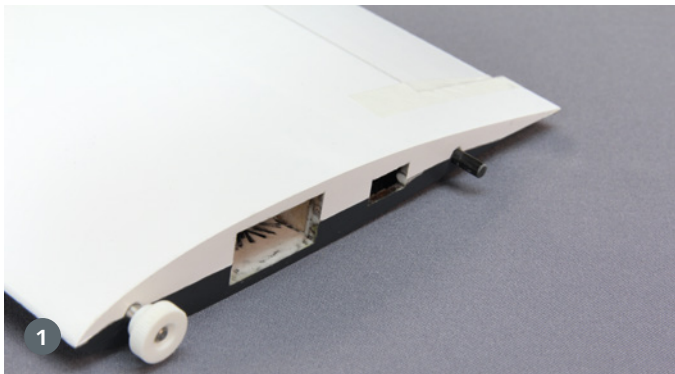
1) Bei den Tragflächen ist die Steckung zum Rumpf hin fertig vorbereitet, gesichert wird die Tragfläche durch eine Rändelschraube aus Kunststoff. 2) Im ersten Schritt wurden die Servorahmen eingeklebt und erst dann die Position der Anlenkungen festgelegt sowie auf der Flügeloberseite ausgefräst
