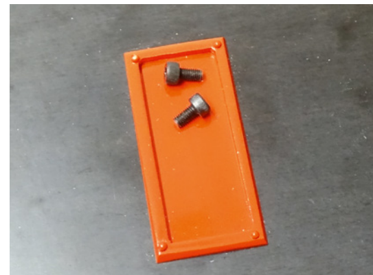
Zwei Magnete unter einer roten GFK-Platte dienen zur sicheren Ablage von kleinen Schrauben
