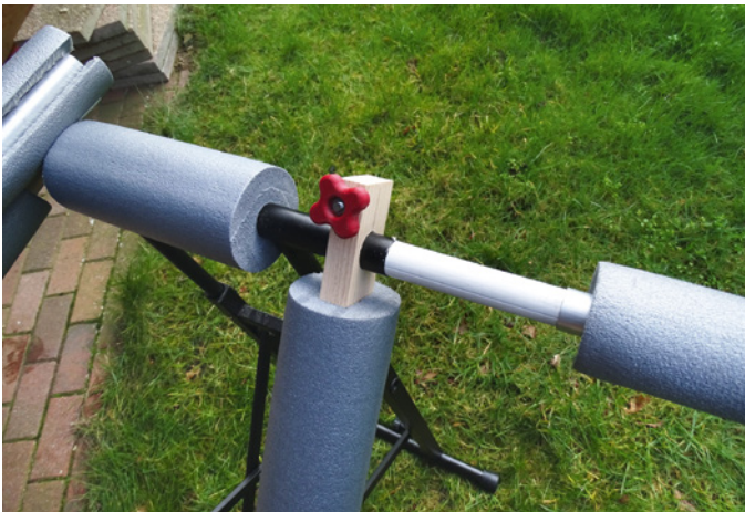
Die Auflagefläche lässt sich durch einzuschiebende Alu- und Kunststoffrohre um bis zu 500 mm flexibel erweitern
