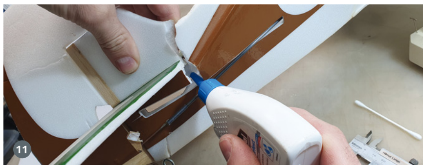
8) Diesen nutzen wir erst zum Vorbohren und setzen ihn dann mit Leim ein
