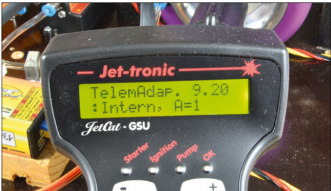
Für eine Telemetriennutzung sind zwei Einstellungen in der GSU notwendig
