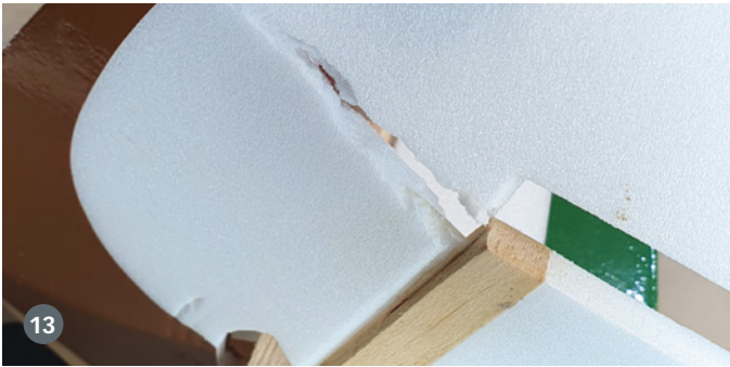
13) Dieser Riss im Seitenruder wird mit der Weißleim-Stecknadel-Methode bestimmt wieder halten
