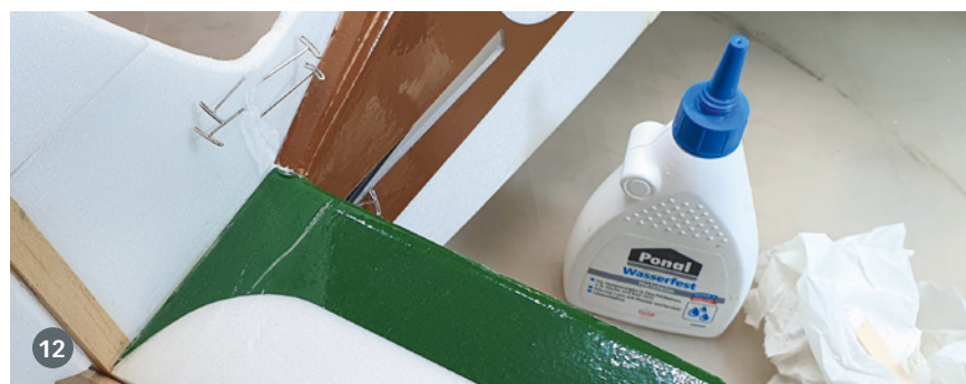
11) Auch bei dieser kapitalen Schadensstelle kann man sich auf Weißleim verlassen. 12) Das Wichtigste ist zudem eine sichere Fixierung, zum Beispiel mit Stecknadeln
