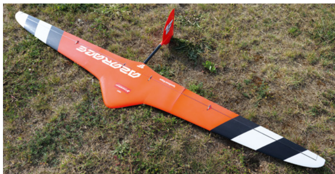
Alle Ruderanlenkungen kommen oben aus der Fläche
