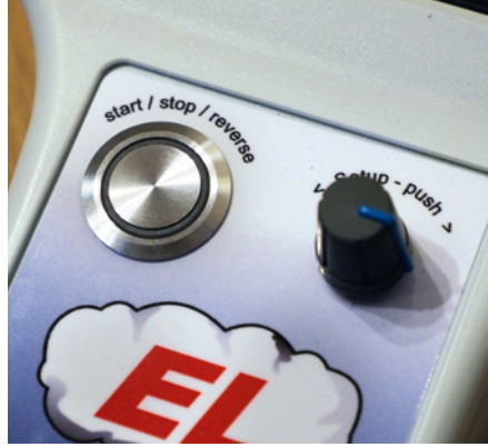
Die komplette Steuerung und die Eingabe der Werte erfolgt über den Button und den Drehgeber
