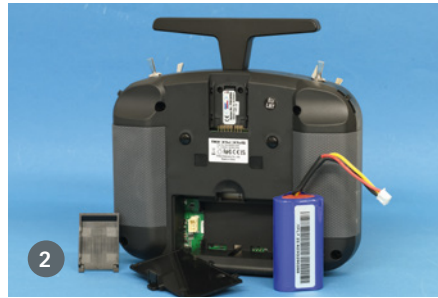
1) Nur 5 g wiegt der kleine 6-Kanal-Empfänger mit Twin-Technologie, die noch mehr Empfangssicherheit gewährleistet. 2) Lite-Module lassen sich im oberen Modulschacht anschließen und unten hat der 2s-Li-Ion-Akku genügend Platz, der über 7 Stunden Betriebszeit ermöglicht. 3) Der Geberausbau der X14S ist für die Senderklasse sehr gut
