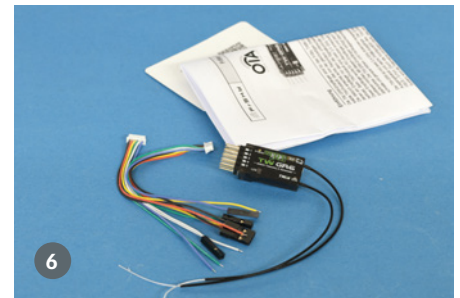
4) In der X14S sind hochwertige, kugelgelagerte Alu-Gimbal mit präzisen Hall-Sensoren eingebaut, die ein sehr gutes Feedback geben. 5) Beim Importeur Engel gehören eine deutschsprachige Kurzanleitung und USB-C-Ladekabel zum Lieferumfang. 6) Besonders am Twin-fähigen Empfänger GR6 ist die niedrige Latenzzeit, die ihn auch für sehr schnelle Modelle prädestiniert
