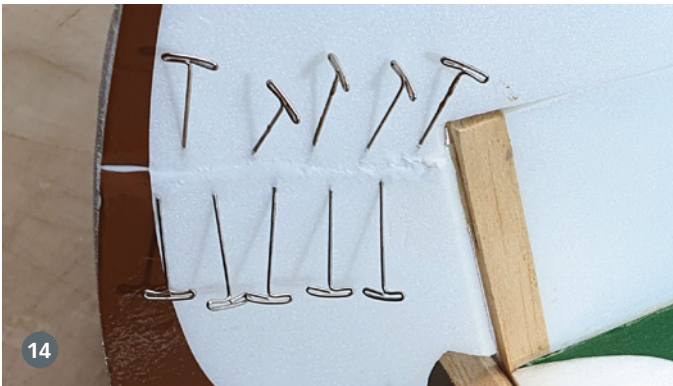
14) Wichtig ist, saubere und hochwertige Nadeln zu verwenden, die glatt durchs Depron gehen
