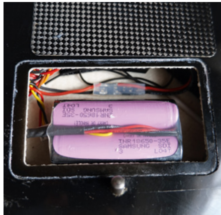
In der Flügelnahe ist Platz für die Li-ion-Akkus, Empfänger und Trimmgewicht
