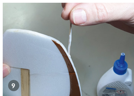
9) Darauf achten, dass Leim auch im unteren Lochbereich ankommt
