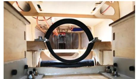
Der recht große Schalldämpfer muss im Rumpf gelagert werden. Ich habe hierfür eine zweiteilige Edelstahl-Schraubroherschelle verwendet. Die beiden Verschraubungen der Schelle werden auch gleich zur Befestigung im Rumpf genutzt. Hierfür sind nachträglich Auflagen mit Einschlagmuttern an der Rumpfstruktur eingearzt worden
