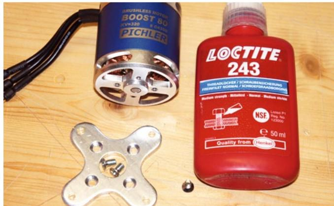
Beim Zusammenbau der Motoreinheit wird Schraubensicherungslack verwendet
