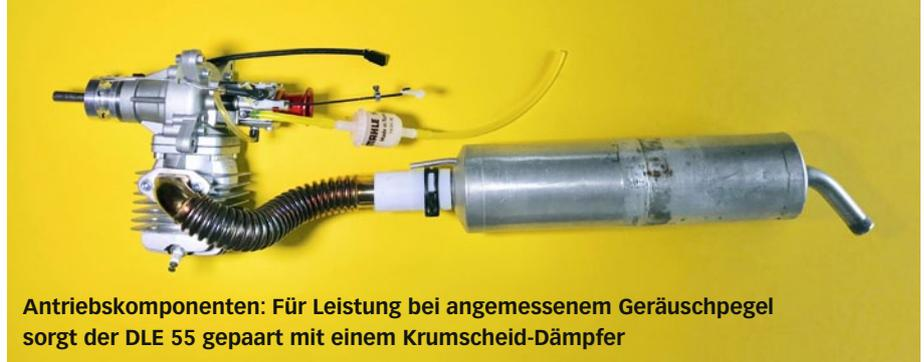
**Antriebskomponenten: Für Leistung bei angemessenem Geräuschpegel sorgt der DLE 55 gepaart mit einem Krumscheid-Dämpfer**
