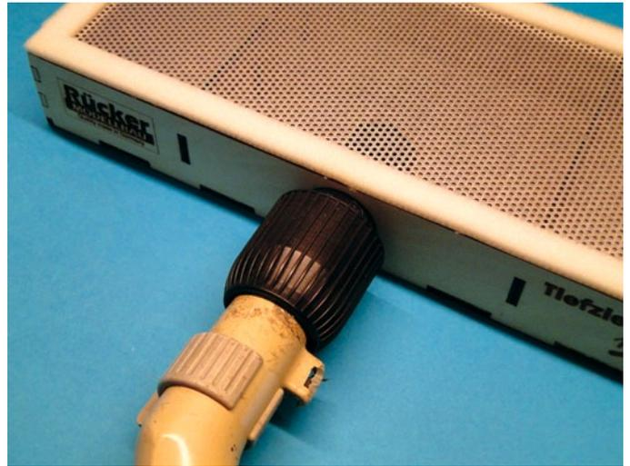
Über den Adapter wird der Staubsauger mit der Box verbunden
