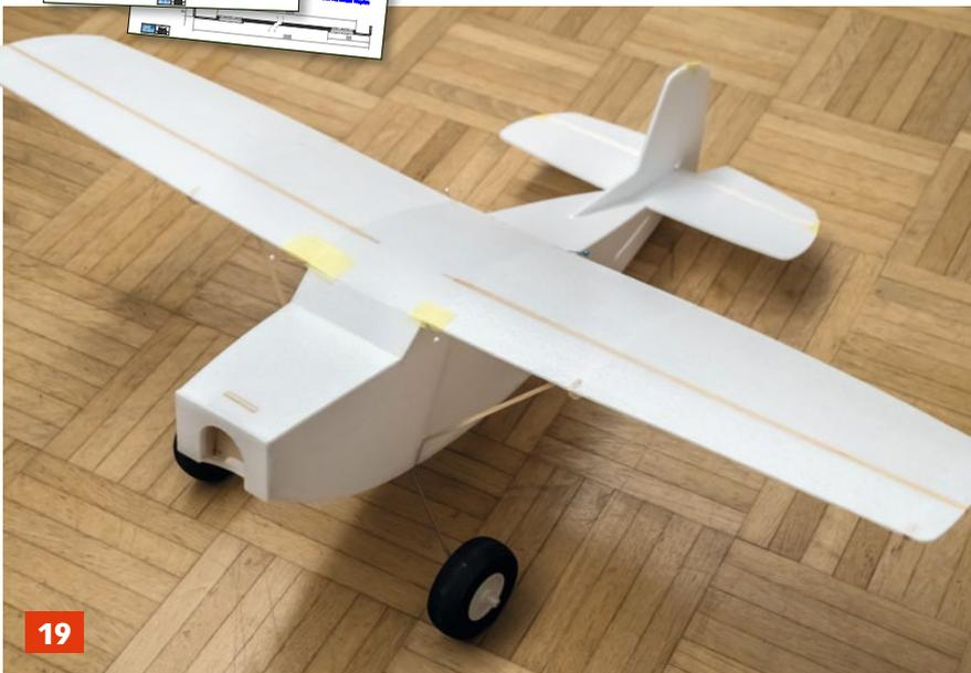
19. Hier steht das rohbaufertige Flugzeug, bereit für die Lackierung. Ich nehme dazu die Räder herunter und klebe den Motor ab. Dann kommt die Grundfarbe aus einem wasserbasierenden Sprühdosenlack, zum Beispiel von Marabu, in diesem Fall in hellgrau. Alle anderen Farbflächen klebe ich aus Vinylfolie aus dem Werbereich auf. Oracal 651 und 751 haften hervorragend und sind sehr dünn und anschmiegsam. Alternativ kann auch mit wasserbasierenden Abtönfarben der Pinsel geschwungen werden
