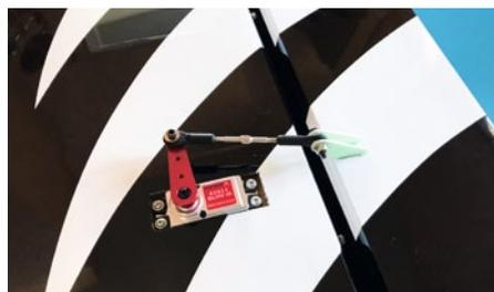
Serie bei der ARFSV-Version: Solide Ansteuerung der Querruder durch HV-Digitalservos der 30-kg-Klasse mit Metall-Abtriebshebel und 3-mm-Gestänge
