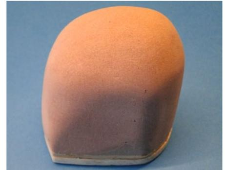
Der „Sockel“ aus Holz unter dem eigentlichen Tiefziehteil ermöglicht ein sauberes Abformen bis ans untere Ende der Form
