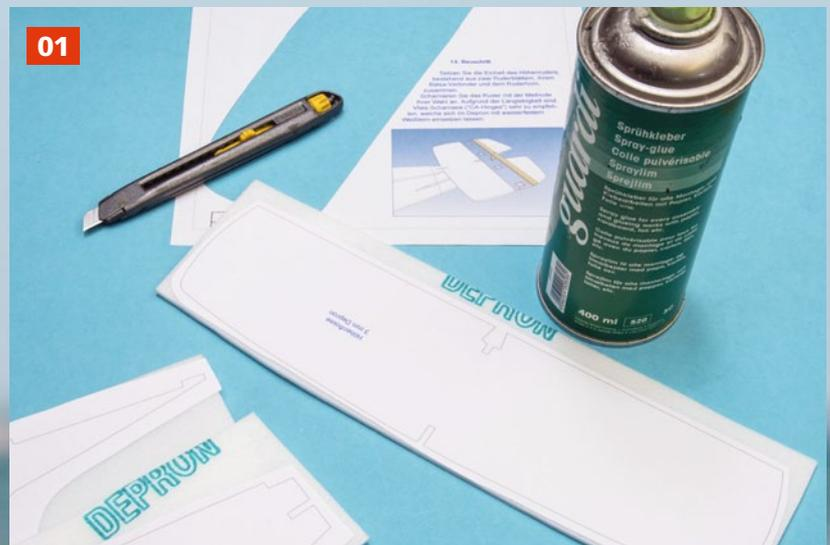
**01.** Aus gut 400 mm Entfernung sprüht man einen Hauch Sprühkleber auf die grob ausgeschnittenen Papierelemente, wodurch sie bereits gut am Depron haften. Man sollte sie nachher rückstandsfrei wieder abziehen können, deshalb darf man es mit dem Kleber nicht übertreiben. Beim Depron kommt ausschließlich 3 mm starkes Material zum Einsatz
