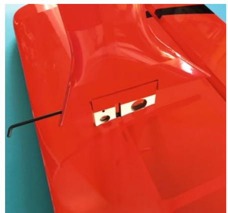
Die Sockel sind bereits mit Bügelfolie überzogen und müssen nur noch in die Schächte der Flächenhälften geklebt werden
