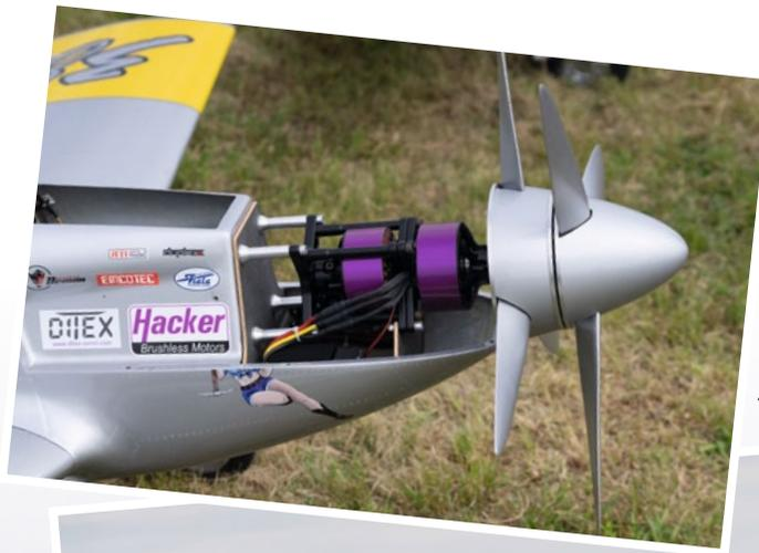
Gegenläufiger Propellerantrieb durch Hohlwelle. Realisiert hat diese Idee kein geringerer als Markus Rummer, der bereits mit der Vektorsteuerung für Großmodelle für Aufsehen sorgt
