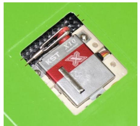
Damit die Gestänge beim Verkleben der Servorahmen auch exakt fluchten, haben wir die Lage der Anlenkungsgestänge mit einem Marker angezeichnet
