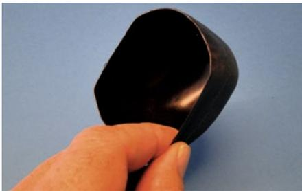
Mit dem Tiefzieh-Verfahren lassen sich dünnwandige, leichte Teile fertigen, wie diese Motorhaube für eine Piper
