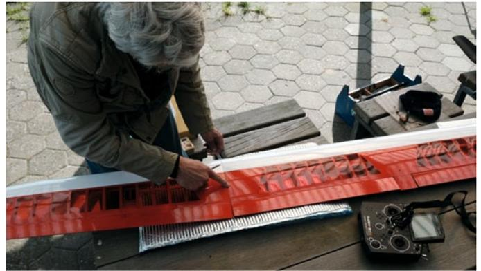
Tesastreifen reichen zur Fixierung der aufgesteckten Außenflächen völlig aus. Dafür ist über die Folienbespannung noch jeweils ein Streifen einer dickeren, transparenten Folie aufzuziehen, die verhindert, dass der Fixierungsklebestreifen beim Abziehen die Bespannfolie hochhebt
