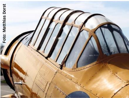
Zum Ein- und Ausstieg können das vordere und hintere Segment der Kabinverglasung aufgeschoben werden
