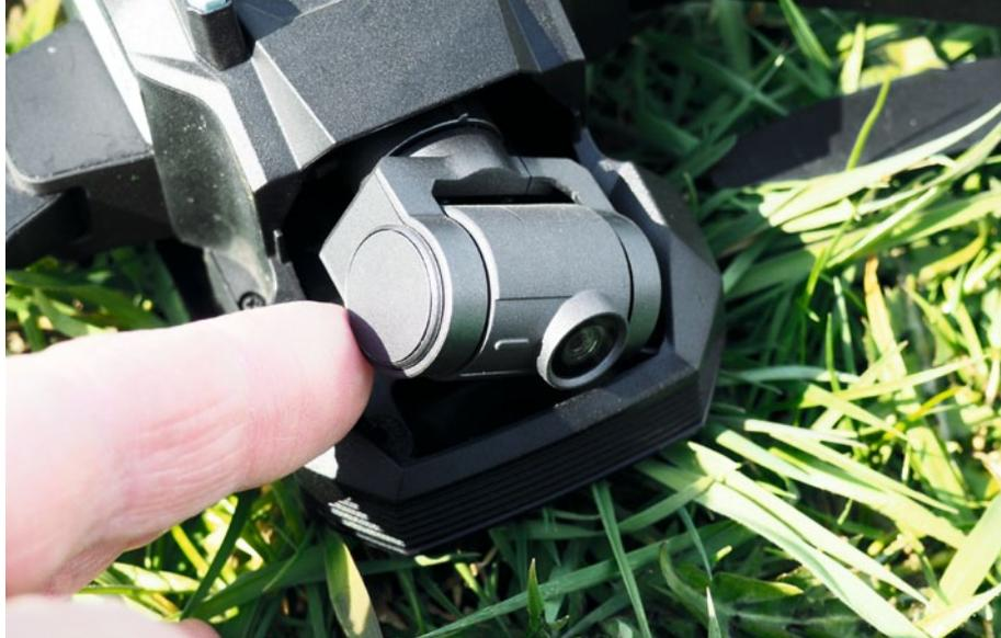
**Die Gimbal-stabilisierte Kamera ist das herausragende Feature und sorgt für exzellente Foto- und Videoaufnahmen. Bereits beim Prototypen aus der frühen Entwicklungsphase funktionierte das perfekt**
