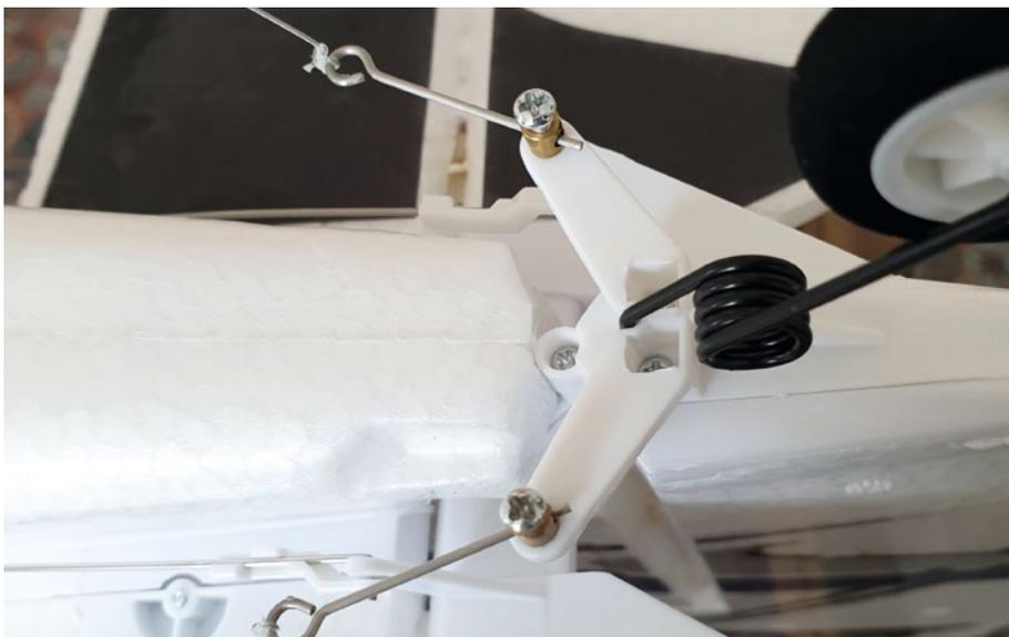
Die Anlenkung der beiden Wasserruder an den Schwimmern wird über Perlon-Steuerleinen realisiert, die mit dem Seitenruder verbunden werden. Dazu werden die Drahtstifte in die beiden beweglich gelagerten Stellringe eingeschoben und mit Schraubchen gesichert – klappt hervorragend
