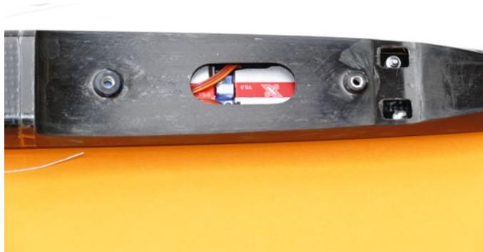
Beide Flächenbefestigungen und die beiden Querruder-Steueranschlüsse. Ja, es passt alles, aber ist verdammt fummelig
