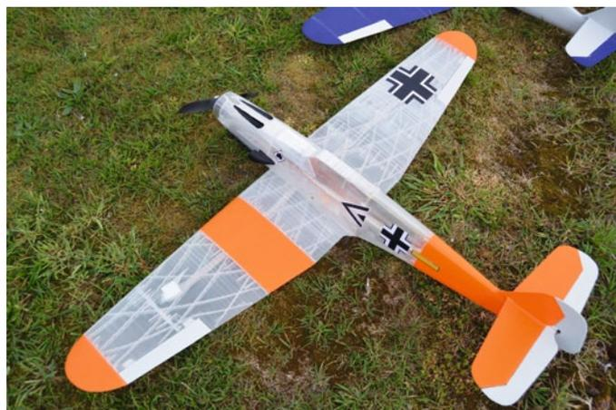
Ohne Lackierung ist die gesamte Konstruktion und auch die Herkunft als 3D-Druck-Modell sehr gut erkennbar
