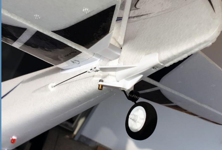
Seitenruder und Spornfahrwerk sind fertig montiert. Lediglich die bereits verlegte Bowdenzug-Verbindung für die Höhensteuerung muss noch eingehängt und gesichert werden
