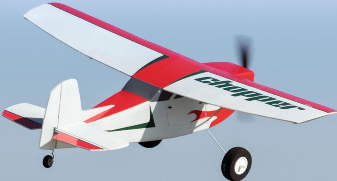
Wenn Sie ohne Verzüge gebaut und den Schwerpunkt korrekt eingestellt haben, wird Chopper bei Halbgas aus der Hand geradeaus sanft wegsteigen. Auch im Bodenstart ist das Modell sehr folgsam, wenn es auch die Heckrad-typische Tendenz zum Ausbrechen besitzt. Mit etwas Übung steuern wir das weg – schließlich fliegen wir einen waschechten Trainer, nur eben in klein
