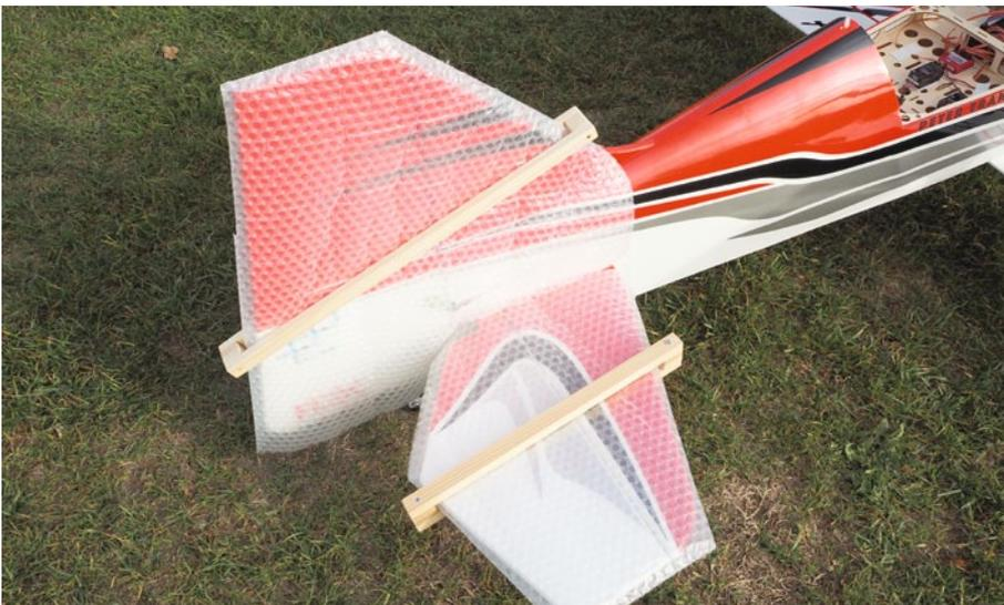
Als Transportschutz wurden erstens Taschen aus Luftpolsterfolie hergestellt (Gefrierbeutel und Folienschweißgerät) und zweitens Fixierungen der Ruderklappen aus Kieferleisten. So wird eine Beschädigung der Ruder und Servogetriebe beim Transport vermieden
