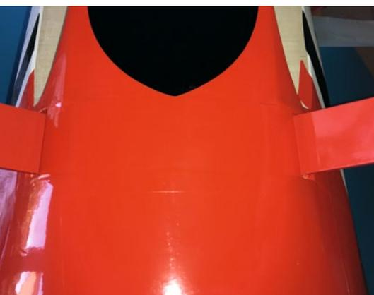
Das lackierte Aluminium-Fahrwerk wird mit vier M4-Schrauben an der Rumpfstuktur befestigt. Leider finden wir im Bausatz kein Formteil, das diesen Bereich passend zur Rumpfkontur verkleidet. Aus Balsa lässt sich so ein Formteil aber recht einfach herstellen, es wird passgenau beigeschliffen und mit Bügelfolie überzogen. Die Befestigung erfolgt ebenfalls durch Bügelfolie
