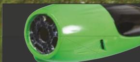
+ eingeharzter Carbon Motorspant
