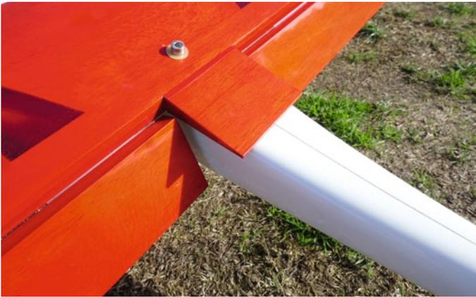
Bei den Wölbklappen lassen sich sehr große Ausschläge realisieren, sie werden damit dann zu reinen Bremsklappen. Dazu müssen sie an der Flügelunterseite angeschlagen und entsprechend angelenkt werden
