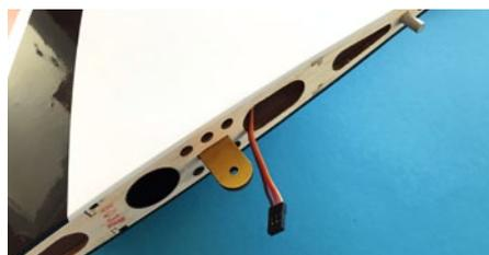
Die vier Flächenhälften verfügen über je eine GFK-Lasche. Anhand dieser werden die Flächen am Rumpf und im oberen Flächenmittelstück mit je einer M4-Schraube gesichert
