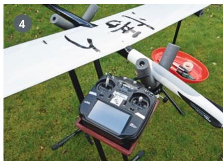
1) Einfach, stabil und gut sind die Rohrhalterungen. 2) Nicht nur für größere Spannweiten ist die Tragflächenstütze eine wertvolle Hilfe. 3) Auch bei der Flächenmontage ohne eine eigenstabile Flächensteckung leistet die zusätzliche Stütze Hilfe. 4) Mit der Senderablage in Arbeitshöhe macht das Einstellen der Ruder nochmal so viel Spaß und die gepolsterten V-Auflagen sind auch für extrem dünne Rümpfe bestens geeignet
