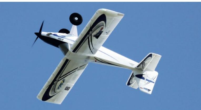
Ohne Vorflügel und mit einem 4s-Akku geht es richtig zur Sache. Da macht das Turnen Spaß und selbst Torquen ist möglich. Aufgrund des Profils muss aber in Rückenlage entsprechend mehr Tiefe gegeben werden, als man es von einem reinen Kunstflieger gewohnt ist
