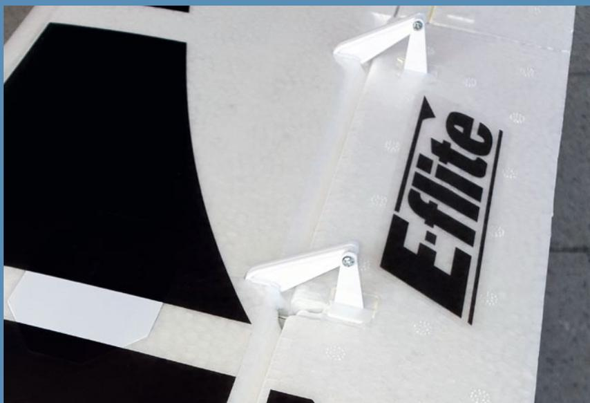
Die als Spaltklappen ausgeführten Landehilfen wirken gerade im Langsamflug erheblich effektiver als die allgemein bei einfacheren Modellen verwendeten Wölbklappen
