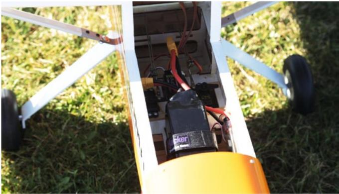
**Der Akku muss weit nach vorne an den Motorspant geschoben werden**
