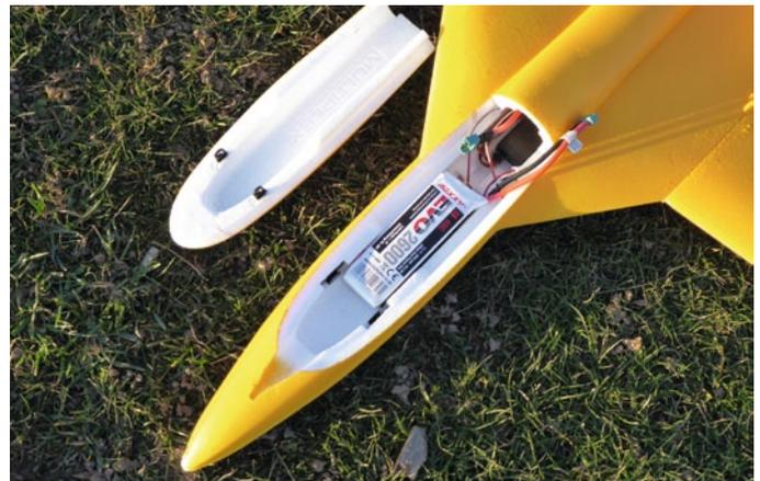
Der Akkuwechsel geht dank der großen Klappe sehr leicht und schnell von der Hand
