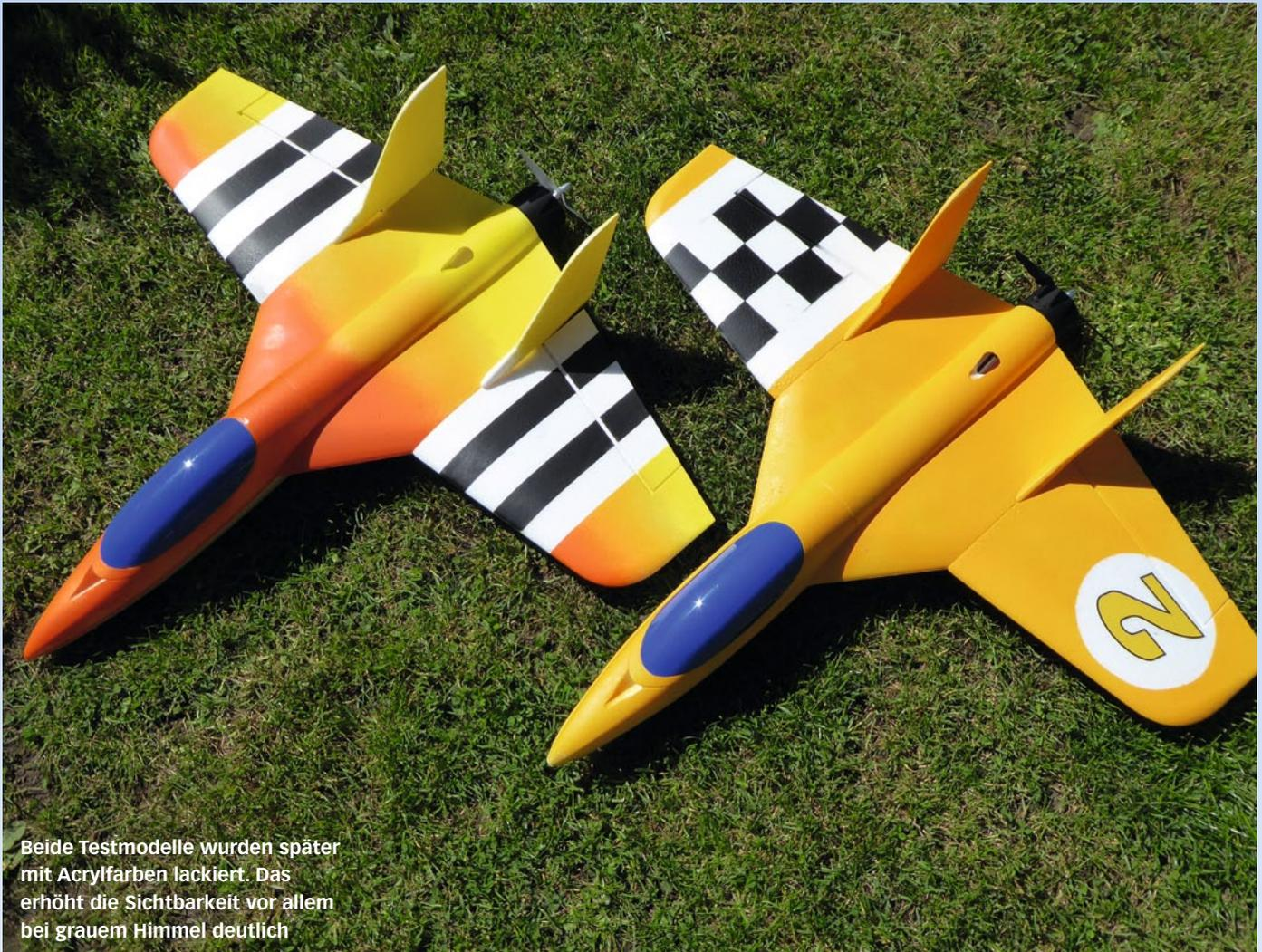
Beide Testmodelle wurden später mit Acrylfarben lackiert. Das erhöht die Sichtbarkeit vor allem bei grauem Himmel deutlich
