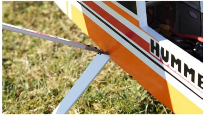
**Am Rumpf wird die Strebe mit einem Splint befestigt**
