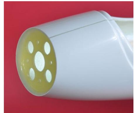
**Ab Werk ist im GFK-Rumpf ein Motorspant eingearzt. Wenn dazu die Bohrungen am Motor passen, ist der Ausbau schnell gemacht**
