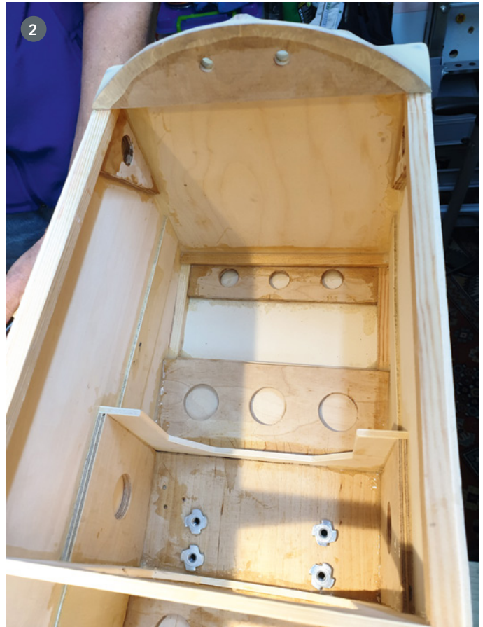
1. Um etwas Gewicht einzusparen, wurden der Rumpfdeckel und der Nackenschutz etwas erleichtert. Das brachte allerdings nur 130 g Mindergewicht. 2. Verwendet man das Elster-Fahrwerk, muss die Aufnahme am Rumpf vor den Rumpfknicke verlegt werden. Ein zusätzlicher Halbspann und die zwei Seitenwandverstärkungen waren selbst herzustellen. 3. Der Tank lagert im Bereich des Steckungsrohrs nahe des Schwerpunkts. Auch die Spanten der Tankaufnahme sind selbst herzustellen
