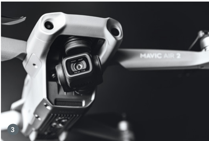
1. Der 3.500-mAh-Akku ermöglicht eine Flugzeit von rund 30 Minuten. 2. Wie üblich bei DJI-Drohnen, finden sich auf der Unterseite einige Sensoren. Außerdem sitzt hier eine zuschaltbare LED, damit die Sichtsysteme auch bei schlechten Lichtverhältnissen optimal arbeiten können. 3. Herzstück der Mavic Air 2 ist die neue 48-Megapixel-Kamera. 4. Zusammengeklappt nimmt die Drohne kaum mehr Platz weg als ihre Fernsteuerung
