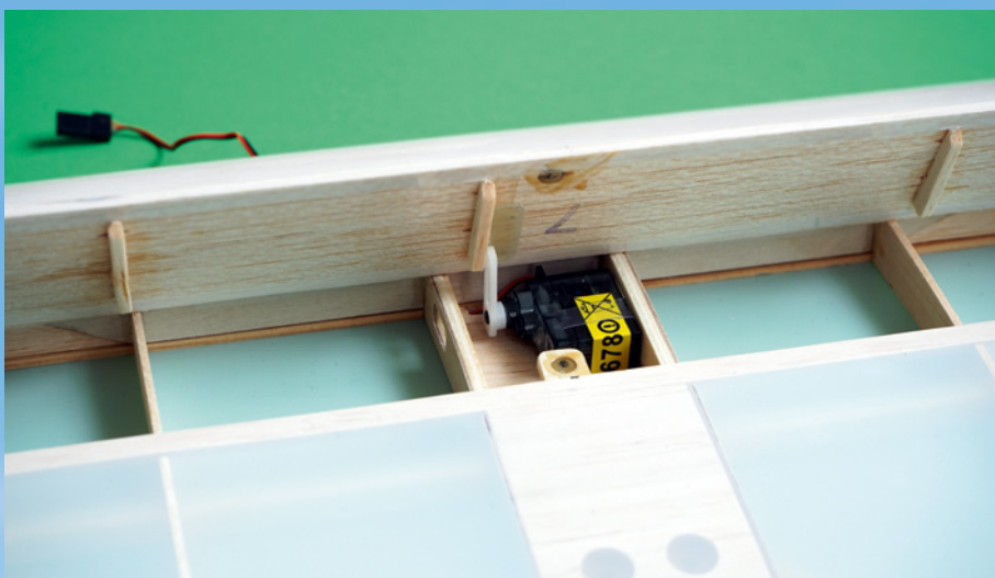
Typisch für RES-Modelle ist eine Bremsklappe. Hier wird sie vom Servohebel „aufgeschoben“. Ein Magnet holt die Klappe dicht
