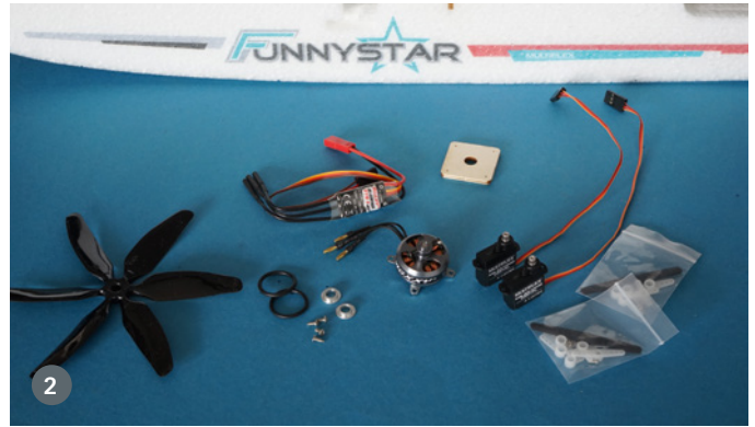
1. Für die Ruderhebel bietet sich Sekundenkleber an. Man muss jedoch die korrekte Einbauposition beachten, sonst klappt es später nicht mit dem Anlenken. 2. Hat man die Version Funnystar-BK+ erworben, bekommt man exakt passende Servos, Brushless-Motor und -Regler, den Sechs-Blatt-Propeller und Zubehör. Sie sind ideal aufs Modell abgestimmt
