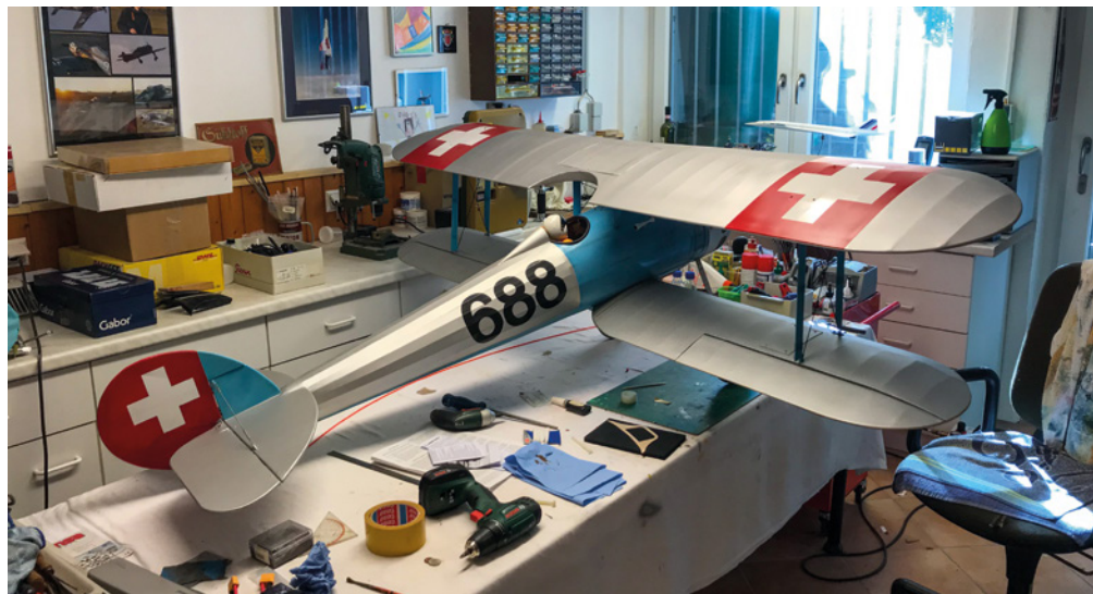
Das fertig bespannte und mit Revell-Enamel sowie Hobby-Color-Acryllack lackierte Modell ist bereit zum Weathering und Washing. Die Kennung ist übrigens aus hauchdünner Folie geplottet
