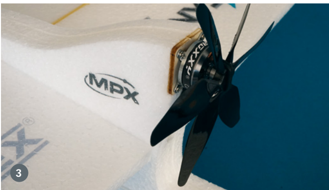
3. Montiert am vorgesehenen Sperrholzmotorspant, sitzt der Außenläufer sehr fest. Für einen angenehm leisen und effizienten Betrieb sorgt der Sechs-Blatt-Propeller. 4. Sehr gutes Zubehör zeichnet den Baukasten bei den Anlenkungen aus – für die empfohlenen Servos sind Ausschnitte im Modell vorgesehen, sodass alles passt
