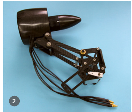
1. Beim Rumpfausbau ist die Bautiefe der Sitzwanne zu berücksichtigen. Das Bremsservo sitzt direkt vor dem Fahrwerk, der Regler sitzt nach dem Servo für die Schleppkupplung. 2. Die Ceflix-Klappimpeller bestehen aus hochwertigen, miteinander verzapften CFK-Bauteilen und alle beweglichen Teile sind kugelgelagert. Das Ausfahren erfolgt per 180°-Servo, das von einer Drehfeder unterstützt wird
