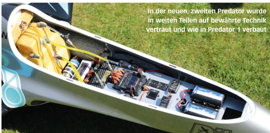
Insgesamt liegt das Volumen der Tanks bei 4,6 l plus einem kleinen Hoppertank. Hier kommt noch der Smoke-Öl-Inhalt hinzu
