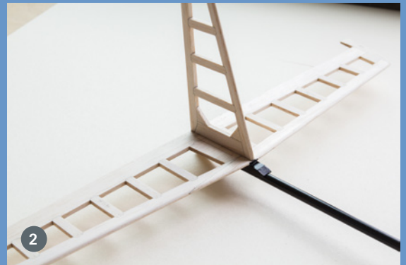
1. Das Antriebssetup für den Helios stammt aus dem Sortiment von aero-naut und sollte ideal zum Konzept eines Leichtwindseglers passen. 2. Ein CFK-Rohr dient als Heckausleger beziehungsweise Leitwerksträger. Die Leitwerke entstehen in klassischer Bauweise
