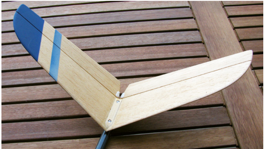
Abbildung 8: Bei einem typischen V-Leitwerk haben beide Flächen einen Winkel von etwa 110° zueinander
