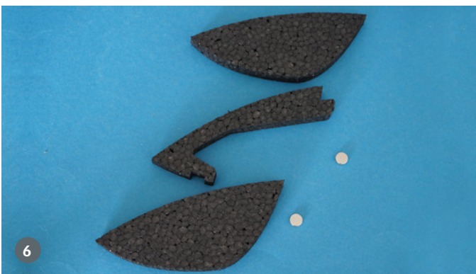
5. Als Schubrohr dienen CFK-Stangen, auf die Klemmspanner zur Rudersteuerung zu kleben sind. Einsteiger müssen aufpassen, dass bei Verwendung von Sekundenkleber dieser nicht in den Bowdenzug läuft. 6. Aus drei EPP-Teilen wird die Kabinenhaube – wieder mit Uhu Por geklebt – erstellt. Magnete halten sie am Rumpf
