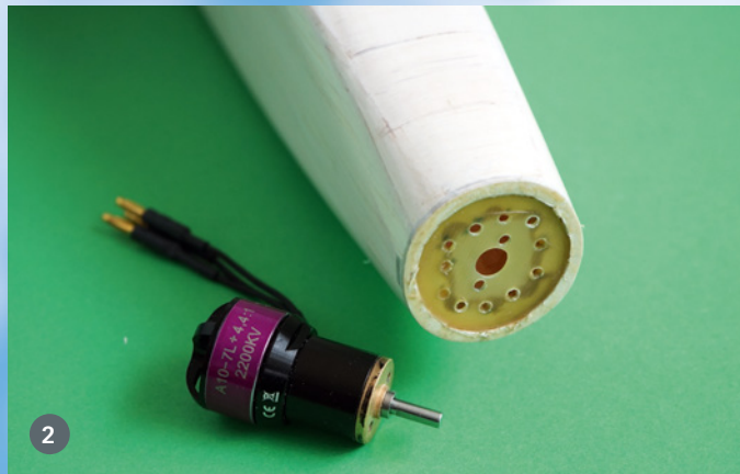
1. Magnete, die noch einzukleben sind, halten den Rumpfdeckel, sind aber auch bei der Bremsklappe und den Flächen zu montieren. 2. Ab Werk ist ein Holzmotorspant in der Rumpfkeule eingeklebt. In der Rumpfnase geht es jedoch so eng zu, dass der Einbau des Hacker-Getriebe-Antriebs fast zwingend ist und damit auch die Montage des CFK-Motorspant erfordert. Dafür ist der Antrieb aber auch ein Traum
