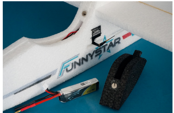
Der Platz im Akkusack ist schmal. Den verwendeten, langen 2s-LiPo mit 450 mAh Kapazität muss man etwas reindrücken, aber zum Glück gibt EPP ja nach
