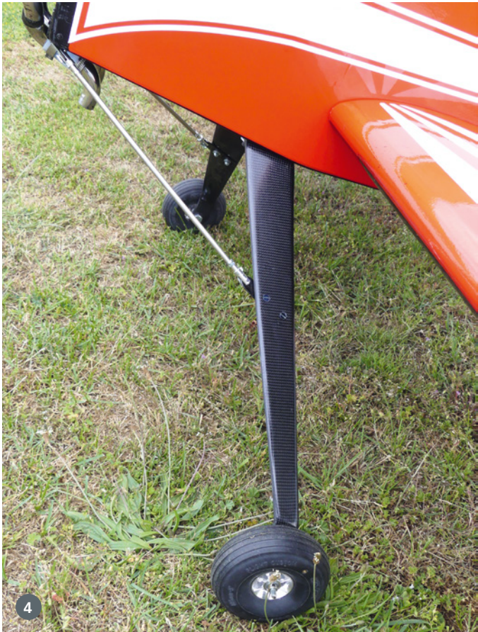
4. Das Carbon-Bügelfahrwerk von Elster ist relativ leicht und hat ein tolles Finish. Die diagonalen Streben sollen die Kräfte aufnehmen, die bei härteren Landungen auf das Fahrwerk nach hinten wirken. 5. Vorne lagern die Fahrwerksstreben über Alu-Winkel am Motorspant. 6. Wegen der nach hinten austretenden Abgasrohre des Ringsammlers musste der Sternmotor etwas mehr Abstand vom Motorträger bekommen. In das Holzteil wurde auch gleich Seitenzug und Sturz eingearbeitet
