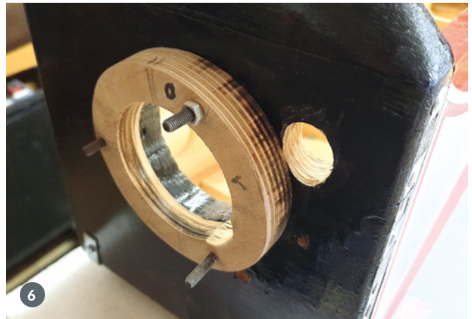
4. Das Carbon-Bügelfahrwerk von Elster ist relativ leicht und hat ein tolles Finish. Die diagonalen Streben sollen die Kräfte aufnehmen, die bei härteren Landungen auf das Fahrwerk nach hinten wirken. 5. Vorne lagern die Fahrwerksstreben über Alu-Winkel am Motorspant. 6. Wegen der nach hinten austretenden Abgasrohre des Ringsammlers musste der Sternmotor etwas mehr Abstand vom Motorträger bekommen. In das Holzteil wurde auch gleich Seitenzug und Sturz eingearbeitet
