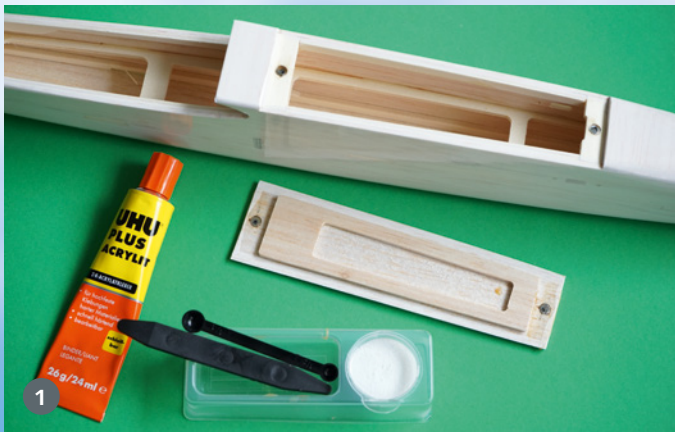
1. Magnete, die noch einzukleben sind, halten den Rumpfdeckel, sind aber auch bei der Bremsklappe und den Flächen zu montieren. 2. Ab Werk ist ein Holzmotorspant in der Rumpfkeule eingeklebt. In der Rumpfnase geht es jedoch so eng zu, dass der Einbau des Hacker-Getriebe-Antriebs fast zwingend ist und damit auch die Montage des CFK-Motorspant erfordert. Dafür ist der Antrieb aber auch ein Traum
