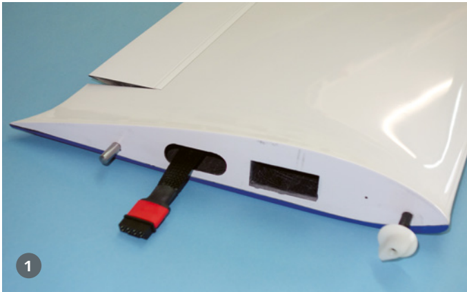
1. Die Tragfläche mit eingebautem Kabelsatz für die Flächenservos. 2. Das Seitenruderservo sitzt an der Rumpfsitenwand und steuert das Ruder über zwei Stahlilitzen an. Diese werden in Bowdenzugrohren am Klappimpeller vorbeigeführt
