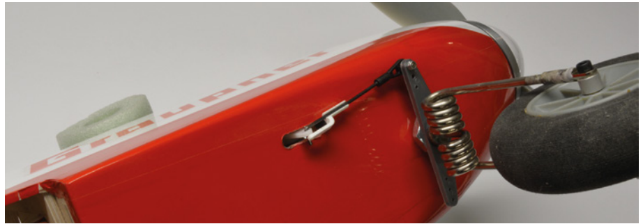
Entgegen des Originalplans wurde die Bugradanlenkung etwas modifiziert. Dadurch lässt sich das Fahrwerk nach einer 180°-Drehung zum Transport einfach abnehmen
