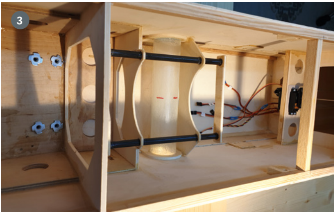
1. Um etwas Gewicht einzusparen, wurden der Rumpfdeckel und der Nackenschutz etwas erleichtert. Das brachte allerdings nur 130 g Mindergewicht. 2. Verwendet man das Elster-Fahrwerk, muss die Aufnahme am Rumpf vor den Rumpfknicke verlegt werden. Ein zusätzlicher Halbspann und die zwei Seitenwandverstärkungen waren selbst herzustellen. 3. Der Tank lagert im Bereich des Steckungsrohrs nahe des Schwerpunkts. Auch die Spanten der Tankaufnahme sind selbst herzustellen
