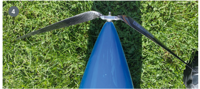
1. Zusammen mit dem FES-Antrieb wurde eine Powerbox Mercury nachgerüstet. 2. Mit dem FES-Antrieb bleiben gut 70 mm Bodenfreiheit bei Einsatz des 20-Zoll-Propellers. 3. Propeller mit 8-mm-Torcman-Adapter. Durch drücken auf den mittigen Pin werden die drei Kugeln entriegelt und die Welle lässt sich ins Rohr stecken. 4. Die Rumpfnase bleibt beim Torcman-System weitgehend unverändert
