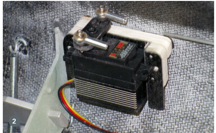
1. Die Tragfläche mit eingebautem Kabelsatz für die Flächenservos. 2. Das Seitenruderservo sitzt an der Rumpfsitenwand und steuert das Ruder über zwei Stahlilitzen an. Diese werden in Bowdenzugrohren am Klappimpeller vorbeigeführt
