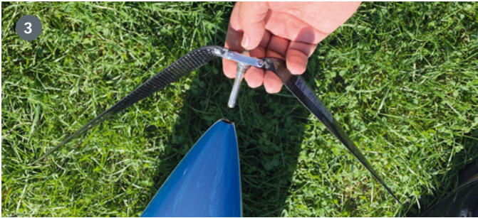
1. Zusammen mit dem FES-Antrieb wurde eine Powerbox Mercury nachgerüstet. 2. Mit dem FES-Antrieb bleiben gut 70 mm Bodenfreiheit bei Einsatz des 20-Zoll-Propellers. 3. Propeller mit 8-mm-Torcman-Adapter. Durch drücken auf den mittigen Pin werden die drei Kugeln entriegelt und die Welle lässt sich ins Rohr stecken. 4. Die Rumpfnase bleibt beim Torcman-System weitgehend unverändert
