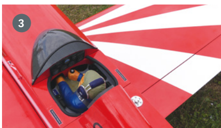
1. Sind Rumpfdackel und Cockpit vom Rumpf abgenommen, hat man alle Einbauten frei im Blick. 2. Der komplette Motorspann ist mit spritfestem Lack versiegelt. Der Rest der Modelle ist mit Oracover-Folie bebügelt. 3. Rechts hinter dem Piloten befindet sich die Schleppkupplung. Diese seitliche Position ist im Schlepp nicht spürbar
