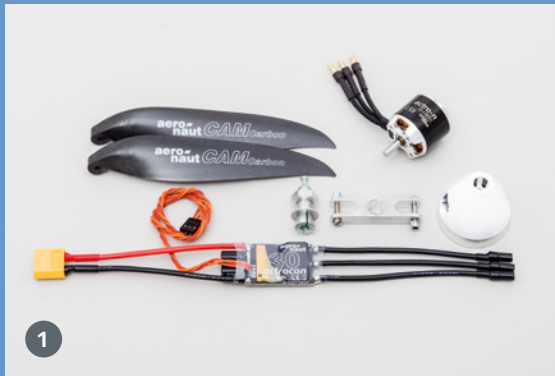
1. Das Antriebssetup für den Helios stammt aus dem Sortiment von aero-naut und sollte ideal zum Konzept eines Leichtwindseglers passen. 2. Ein CFK-Rohr dient als Heckausleger beziehungsweise Leitwerksträger. Die Leitwerke entstehen in klassischer Bauweise
