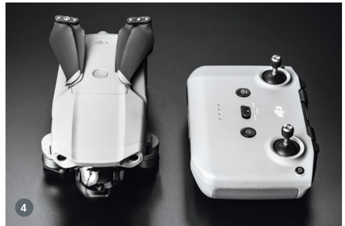
1. Der 3.500-mAh-Akku ermöglicht eine Flugzeit von rund 30 Minuten. 2. Wie üblich bei DJI-Drohnen, finden sich auf der Unterseite einige Sensoren. Außerdem sitzt hier eine zuschaltbare LED, damit die Sichtsysteme auch bei schlechten Lichtverhältnissen optimal arbeiten können. 3. Herzstück der Mavic Air 2 ist die neue 48-Megapixel-Kamera. 4. Zusammengeklappt nimmt die Drohne kaum mehr Platz weg als ihre Fernsteuerung
