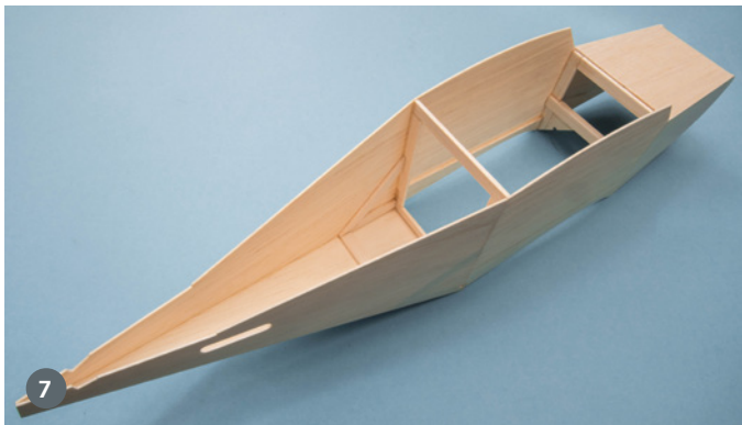
7. Aufgrund der Passgenauigkeit der Teile kann - im Wortsinn - nicht viel schief gehen. Wer es eilig hat, der klebt mit dünnem und mittlerem Sekundenkleber. Genussbauer dürfen auch Weißleim oder Uhu Hart nehmen. Immerhin ist das ein waschechter Vintage-Flieger. 8. Mit Kombizange und Schraubstock entsteht das aus 2-mm-Federstahldraht gebogene Hauptfahrwerk. Ziel ist es, dass es auf dem Baubrett liegend nicht kipzelt. Dann verstärken wir es mit einem Balsadreieck, das einen 6 × 3-mm-Scheibenmagneten beinhaltet. Nähgarn und Sekundenkleber sorgen für dauerhaften Halt am Draht
