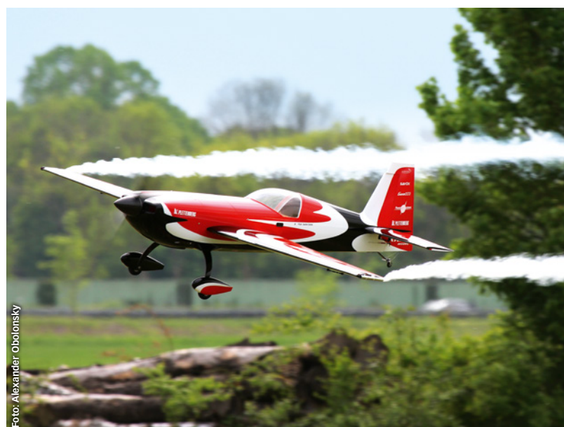
Abbildung 9: Bei der Extra 330 liegt das Cockpit hinter dem Flächenholm
