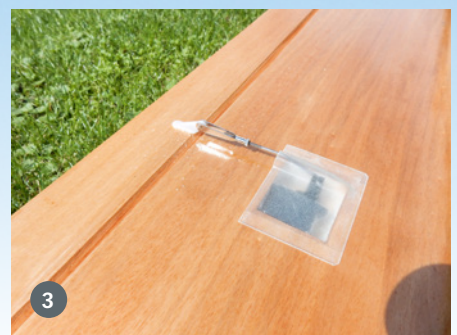
1) Die Ausschnitte für die Servos müssen selbst hergestellt werden, ebenso wie der Kabelbaum. 2) Alle Kabel münden in einem fest installierten grünen Multiplex-Stecker. 3) Die Flächenservos verschwinden unter GFK-Abdeckungen. Bei den Wölbklappenservos ist darauf zu achten, einen langen Ruderweg zu realisieren
