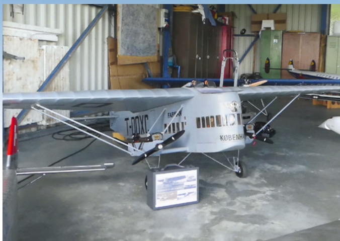
Die französische Farman F-121 Jabiru ist zumindest als Modell eine echte Rarität. Michael Wenzel hat die 3.850 mm spannende Viermot (je Seite zwei Tandem-E-Motoren) in konventioneller Holzbauweise im Maßstab 1:5 gefertigt. Eine Besonderheit bietet die Tragfläche, die bei einer Rumpflänge von 2.700 mm eine Flächentiefe von 1.000 mm aufweist
