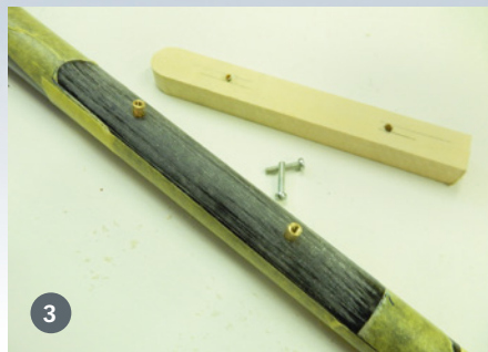
1) Die Landung gelingt dank der gut wirkenden Landeklappen mit Butterflystellung auf den Punkt. 2) Beim Bohren der Befestigungsbohrungen helfen wieder die Styropor-Reststücke, damit auch alles gerade wird. 3) Das Höhenleitwerk ist abnehmbar gestaltet und wird mittels Gewindehülsen, M2-Schrauben und einem Holzklötz auf dem Leitwerksträger gehalten. 4) Beim Einkleben der Seitenleitwerksflosse muss man sich Zeit beim Ausrichten lassen. Am besten geht es senkrecht
