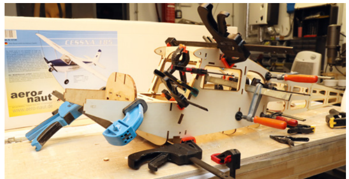
Zahlreiche verschiedene Zwingen und Klemmen helfen beim Bau und halten Hölzer bis zum Aushärten des Klebers in Position
