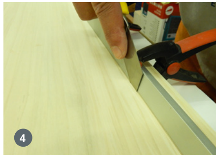
1) Vor dem Verkleben der Mittelstücke ist Platz für die Verstärklötchen der Verschraubung zu schaffen. 2) Man beachte die Maserung des Holzes, sie ist symmetrisch bei beiden Flügelhälften – das ist Liebe zum Detail. 3) Die Klappen werden seitlich mit einer feinen Zugsäge ausgesägt. 4) Entlang eines aufgelegten Alu-Winkelprofils lässt sich mit einem sehr scharfen und stabilen Messer das Querruder austrennen. 5) Hat man alles gemäß Anleitung gemacht, trifft man exakt auf die Verkastung der Ruder
