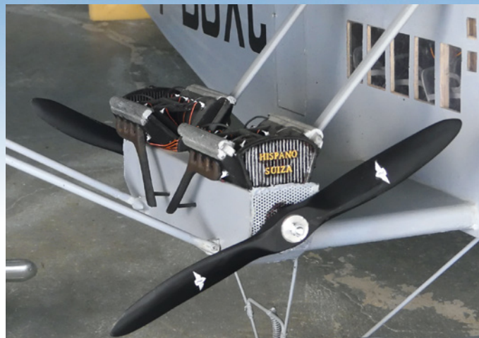
Die französische Farman F-121 Jabiru ist zumindest als Modell eine echte Rarität. Michael Wenzel hat die 3.850 mm spannende Viermot (je Seite zwei Tandem-E-Motoren) in konventioneller Holzbauweise im Maßstab 1:5 gefertigt. Eine Besonderheit bietet die Tragfläche, die bei einer Rumpflänge von 2.700 mm eine Flächentiefe von 1.000 mm aufweist
