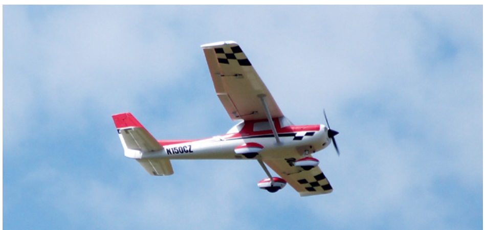
Abbildung 5: Die Cessna 150 gilt als Hochdecker, denn die Tragfläche liegt höher als der Rumpfrücken
