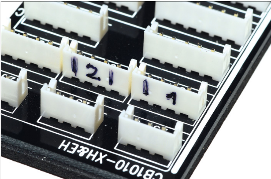
Kennzeichnungen an den Balanceranschlüssen unterstützen die Einhaltung der korrekten Anschlussreihenfolge
