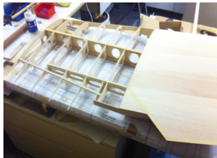
Das Tragflächen-Mittelteil nimmt Gestalt an. Die Fahrwerksaufnahme ist bereits eingeklebt
