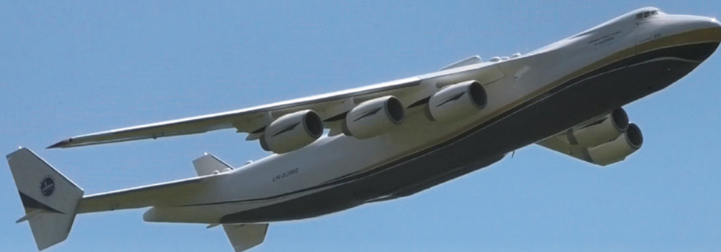
Michael Speiers riesige Antonov 225 wird hybrid-mäßig angetrieben. Die inneren Triebwerke sind mit Turbinen bestückt, während in den jeweils zwei Außengondeln E-Impeller ihren Dienst verrichten. Das 93 kg schwere und 5.900 mm spannende Flugmodell bedurfte eines kleinen Huckels auf der Graspiste als Hilfe zum Abheben
