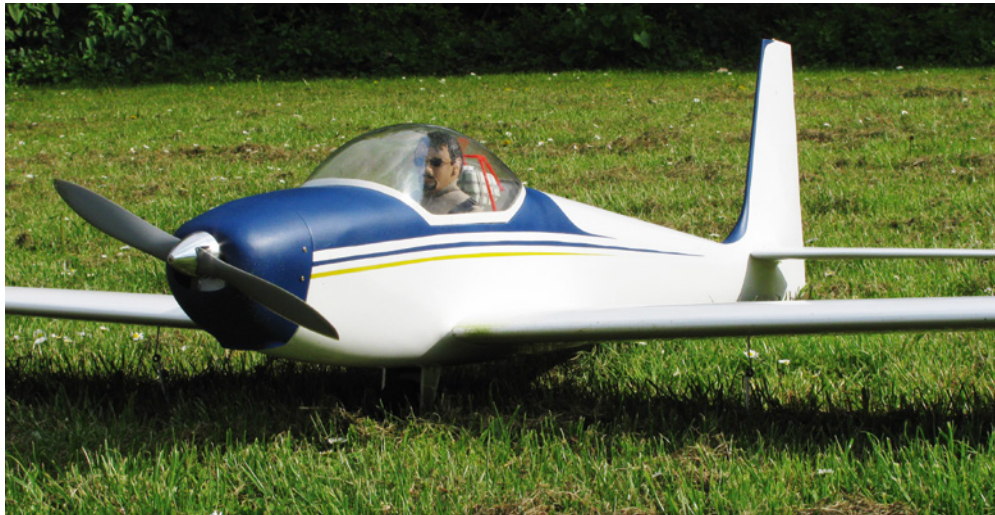
Abbildung 10: Die ASK-14 ist ein Motorsegler in Tiefdecker-Konfiguration
