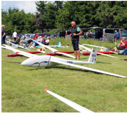
Jörg Vogelsang flog mehrfach seine elegante DG-1000 von Paritech gekonnt vor. Das im Maßstab von 1:2,5 ausgeführte Modell hat eine Spannweite von 8.880 mm und soll knapp unter der 25 Kg-Grenze liegen
