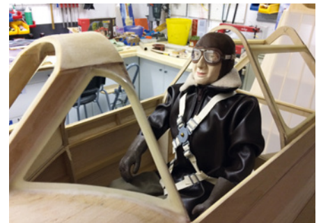
Sitzprobe des Piloten. Auch die Kabine entstand in Holzbauweise
