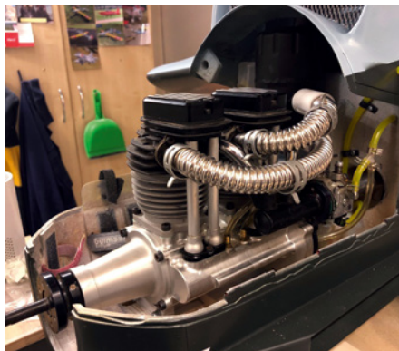
Eingebauter Fiala FM120i2. Die Kühlluftführung erfolgt durch den Ölkühlereinlass über eine Balsaholzkonstruktion verteilt auf die beiden Zylinder. Die erwärmte Luft strömt dann durch den Wasserkühler am Bauch wieder aus (hier nicht eingebaut)
