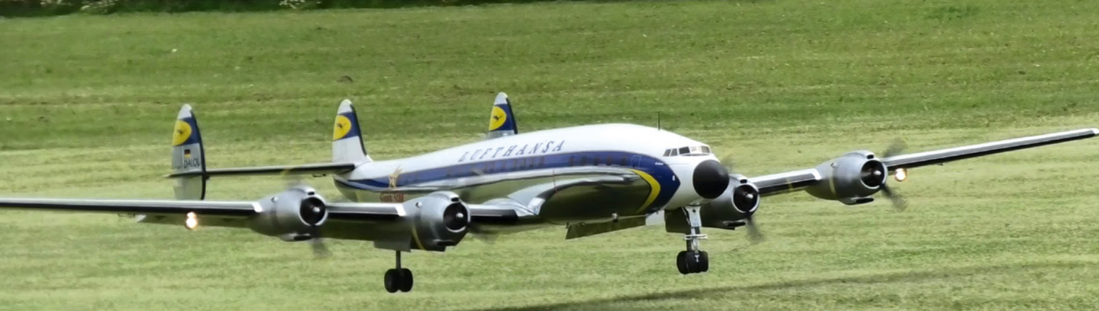
Diese elegante Lockheed L-1649 „Super Star“ stammt aus der Werkstatt von Willi Kling und hatte bereits 1988 einen ihren ersten öffentlichen Auftritt in La Ferté bei Paris. Uli Richter hatte das Modell später übernommen und jetzt einer aufwändigen Generalüberholung unterzogen – einschließlich Umbau auf E-Antriebe
