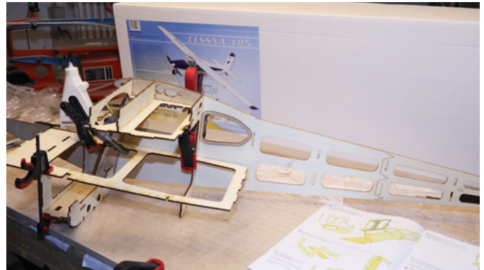
Form erhält der Rumpf durch Kontur-gebende Innenteile, die zugleich tragende Funktionen innehaben
