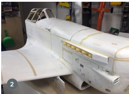
1) Am Heck und insbesondere am Leitwerk wurde so leicht wie möglich gebaut. Die kurze Nase des Modells ist bezüglich des Schwerpunkts ein Problem, weshalb die Steuerflächen auch nur bespannt sind. 2) Teilweise realisiertes Oberflächen-Finish mittels Spachtel, Selbstklebefolie und selbst gegossenen Elementen. Insbesondere die typischen Scharnier-Elemente auf der Seite des Rumpfs sind hier zu erwähnen. 3) Die Morane D-3801 wiegt fertig gebaut 23 kg und hat 3 m Spannweite
