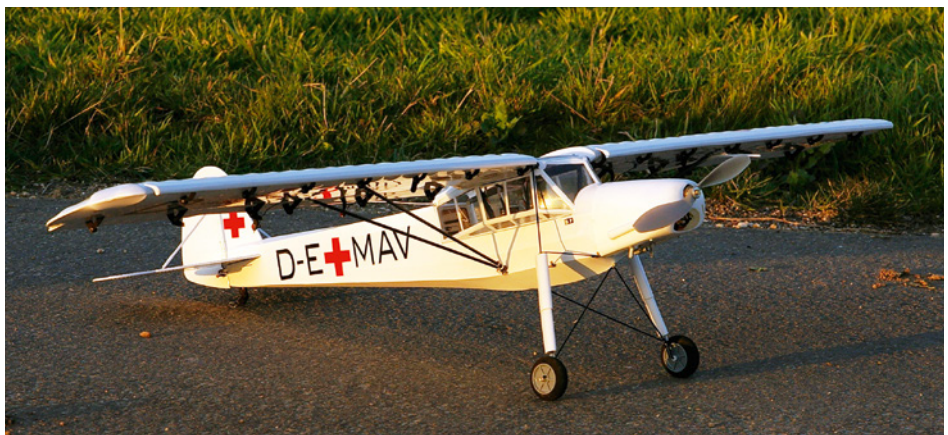
Abbildungen 4a/b: Der Fieseler Storch und die Piper sind tatsächlich „nur“ Schulterdecker, auch wenn die Tragflächen gar nicht höher angebracht werden könnten
