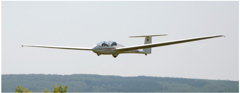
Abbildung 13: Die Twin Astir ist zwar noch gerade so ein Mitteldecker, aber besitzt schon sehr tief liegende Tragflächen
