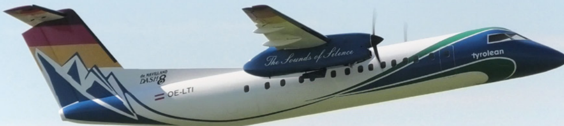
Gerhard Winner hatte seine 3.400 mm spannende, 20 kg wiegende im Maßstab 1:8 umgesetzte Eigenkonstruktion Dash 8 dabei. Selbst die Einziehfahrwerke wurden in Eigenleistung erstellt. Rainer Kamitz flog es vor Ort ein. Sein Urteil: Es fliegt wirklich hervorragend! Antrieb: 2 x 30-cm2-Zweitakter
