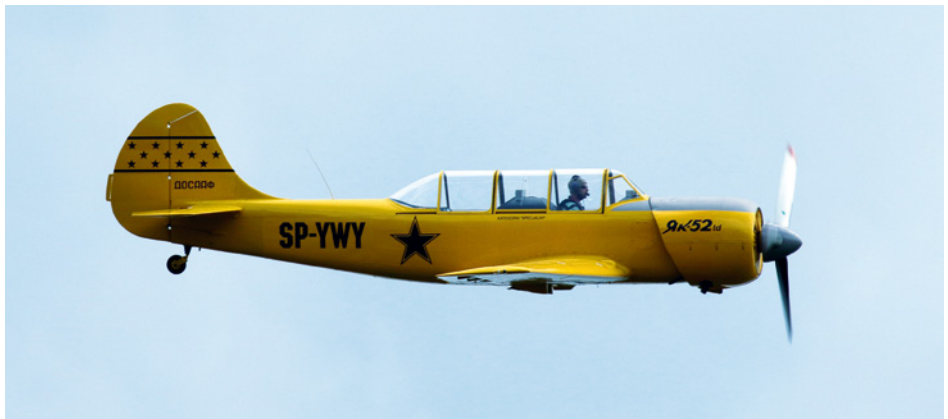
Abbildung 3: Super-Chipmunk, Zlin-526 oder wie hier im Bild die Yak-52 sind typische Vertreter von Kunstflugmaschinen in Tiefdecker-Konfiguration
