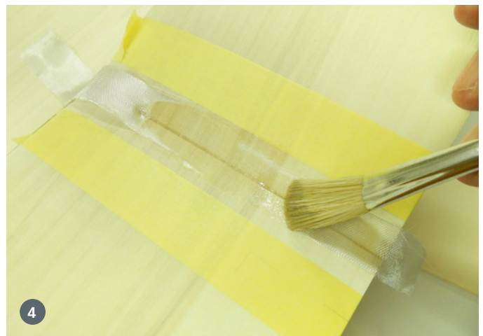
1) Die Holzteile sind edel, die Randbögen bereits verschliffen und am Höhenleitwerk ist das Ruder schon angeschlagen. 2) Zum Schleifen des Gehrungswinkels der geknickten Flügel können die Abfallstücke vom Schneiden der Schaumkerne als Auflage verwendet werden. 3) Die Ohren werden zuerst stumpf an die Außenflügel geklebt. 4) Im zweiten Schritt ist die Knickstelle mit dem beiliegenden Harz und der Glastmatte doppelseitig zu laminieren
