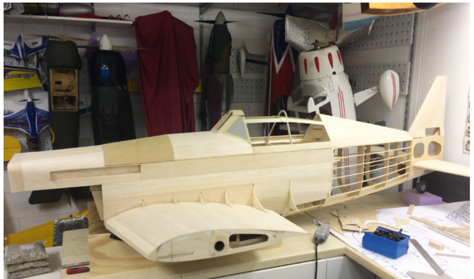
Der Rohbau des Rumpfs ist fast vollendet. Die typischen Formen der Morane sind klar zu erkennen – und auch die Dimensionen des Modells
