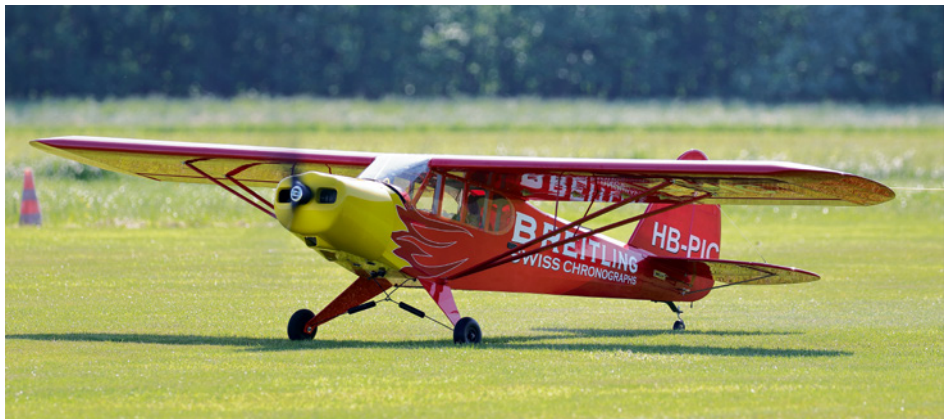
Abbildungen 4a/b: Der Fieseler Storch und die Piper sind tatsächlich „nur“ Schulterdecker, auch wenn die Tragflächen gar nicht höher angebracht werden könnten
