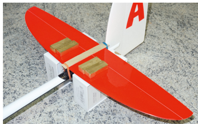
Um das Verkleben des Höhenleitwerk-Pylons zu vereinfachen, haben wir aus einem dünnen Sperrholzstreifen und zwei Gummiringen eine kleine Vorrichtung gebaut, welche die Auflage gegen das Rumpfrohr presst
