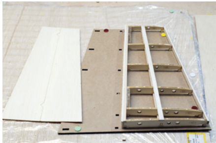
Die beiliegenden Beplankungsbrettchen könnten nach Meinung des Testers gerne dicker ausfallen, um mehr Material fürs Schleifen zu haben
