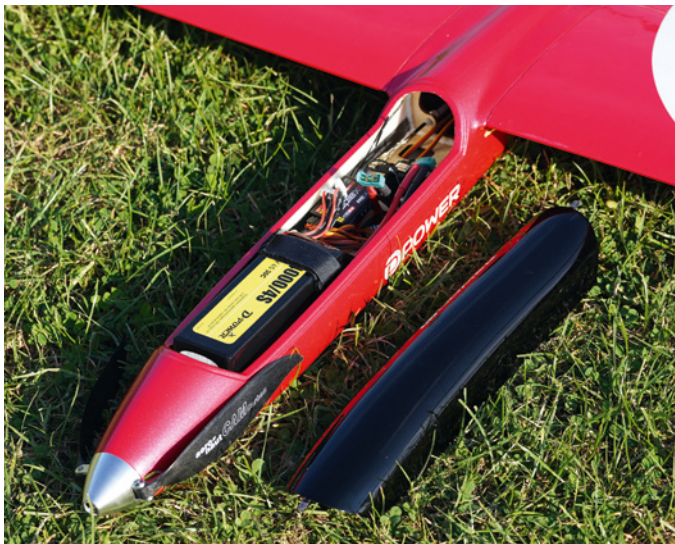
Um den Schwerpunkt einzustellen, muss der Akku nach ganz vorne und ergänzend ein wenig Trimmgewicht in die Nase
