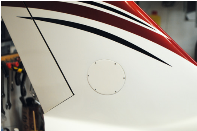
Hinter dem Lochdeckel ist das Servo für das bereits angeschlagene Seitenruder einzubauen
