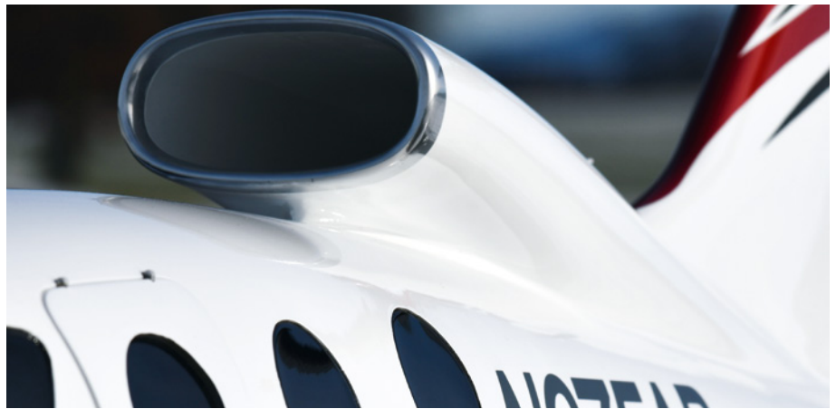
Markant an der Epic Victory ist der optisch formschön integrierte Lufterlasskanal oben auf dem Rumpf, der Luft zur Turbine im Heckbereich führt
