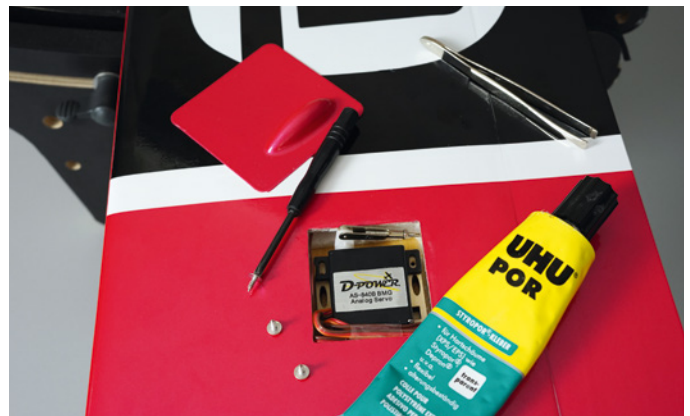
Kleiner Tipp: Ein Tropfen Kontaktkleber auf dem Schraubendreherkopf verhindert, dass die nicht magnetischen Befestigungsschrauben beim Eindrehen verloren gehen
