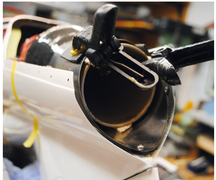
Exaktes Ausrichten des Schubrohrs ist Pflicht, damit die Epic auch perfekt fliegt
