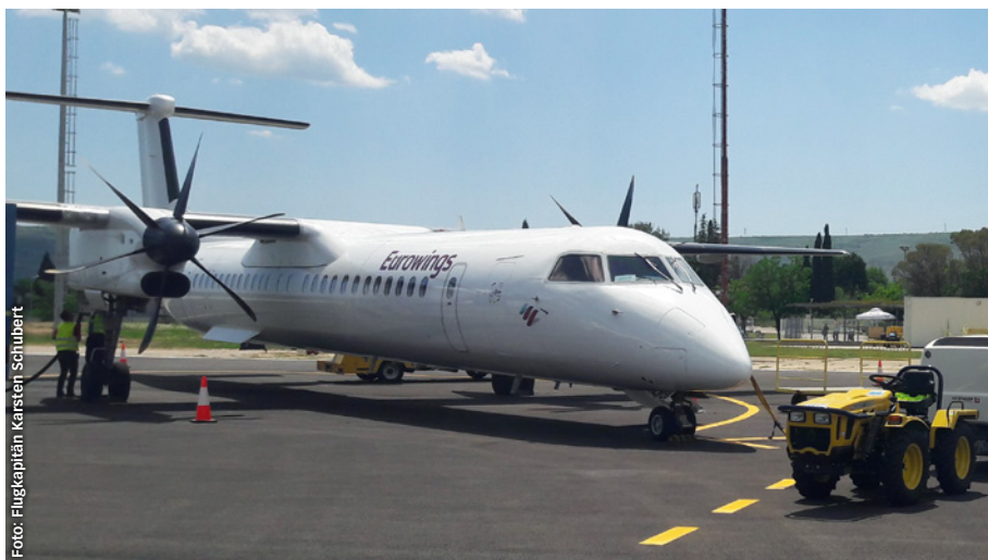
Abbildung 2: Die DHC-8 (Dash 8) ist als Linienflugzeug ein Schulterdecker
