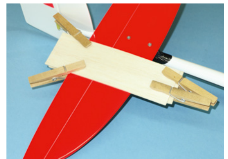
Um beim Vercrimpen der Anlenkungen das Ruder in der Neutralstellung zu halten, helfen diese beiden Balsabrettchen mit den angebrachten Wäscheklammern
