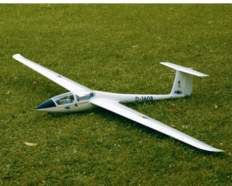
Abbildung 8: Die ASK-21 ist ein typischer Mitteldecker
