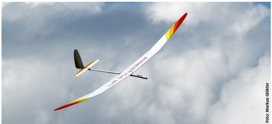
Abbildung 15: Nah dran an einer sehr effizienten Hochdecker-Konfiguration ist der Pike Prestige
