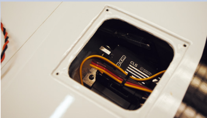
Der Servo-Einbau ist herstellerseitig gut vorbereitet. Die Kingmax-Servos erledigen ihre Aufgabe zuverlässig und genau
