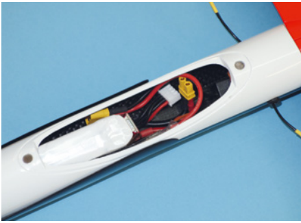
Der Antriebsakku wird vorne unter den Haubenausschnitt geschoben und hinten per Klettband in Position gehalten
