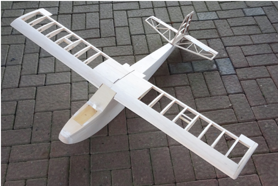
Der Rohbau sieht schon nach Flugboot aus. Ganz wichtig ist, das Holz gründlich gegen Wasser zu versiegeln beziehungsweise zu schützen
