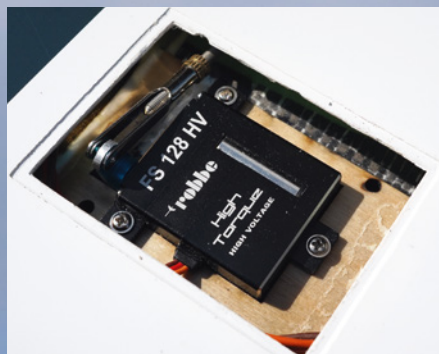
Hochwertige Servos kommen für Höhen- und Seitenruder als auch in den Flächen zum Einsatz
