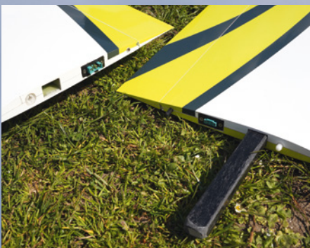
In der PNP-Version sind alle Steckungen und Kabelverbindungen werksseitig erledigt
