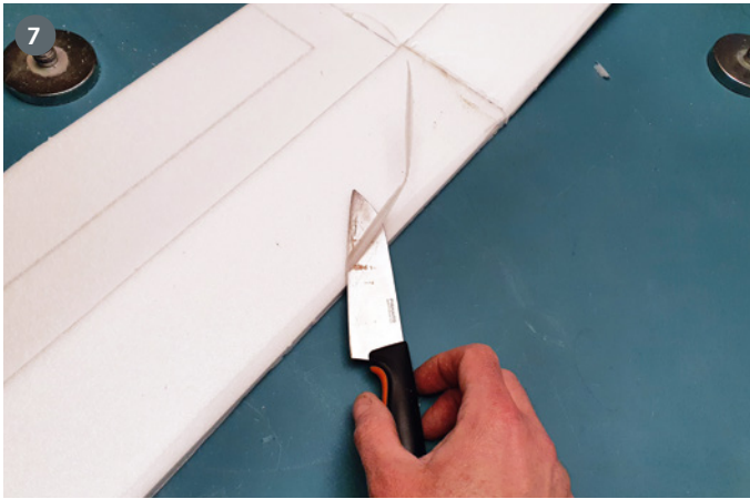
Die Nasenleisten werden zunächst grob in Form geschnitzt, danach kann man alles verschleifen
