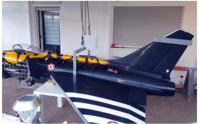
Auswiegen der Rafale zum Einstellen des Schwerpunkts. 61 kg wollen gehoben sein
