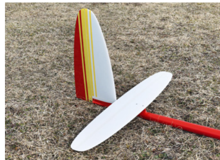
Das vorgesetzte Höhenleitwerk ist ein charakteristisches Konstruktionsmerkmal von Philip Kolb
