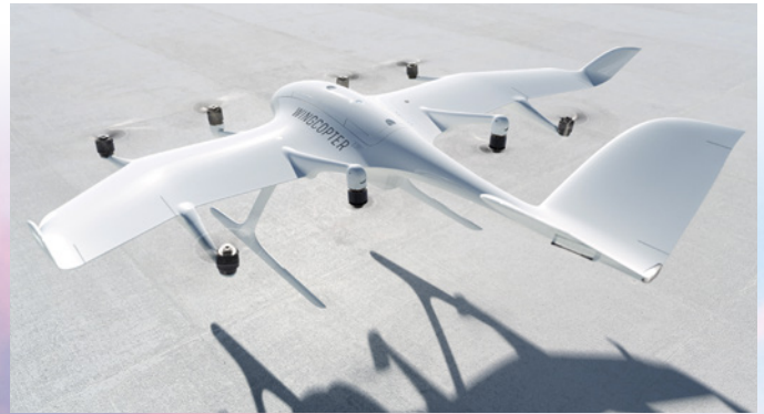
Abbildung 11: Die weltweit eingesetzt Transport-Drohne Wingcopter bezieht ihre VTOL-Fähigkeit aus schwenkbaren Antrieben und ist im Flächenflug energieeffizient unterwegs
