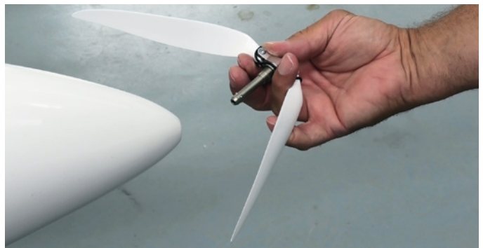
Alternativ zum ausfahrbaren Triebwerk ließe sich auch ein Nasen-antrieb mit demontierbaren Prop für eine Schleppkupplung realisieren
