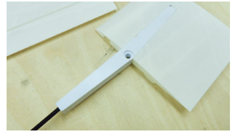
Die Flächensegmente werden einfach aufgefädelt und verklebt
