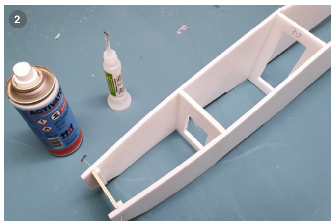
Der Rumpf ist eine einfache Kastenkonstruktion. Drei Spanten reichen
