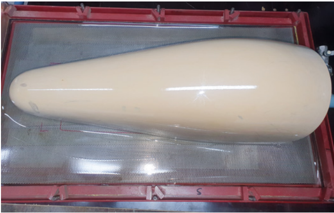
Der Vorderteil der Kabinenhaube wird in Vakuum über das Urmodell tiefgezogen
