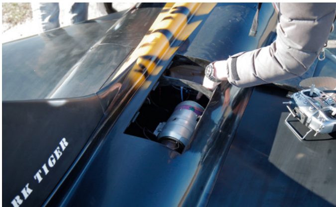
Blick auf den Klappenzugang zur linken Turbine
