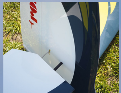
Transportfreundlich und ideal zum fliegen ist das gesteckte Pendelhöhenruder
