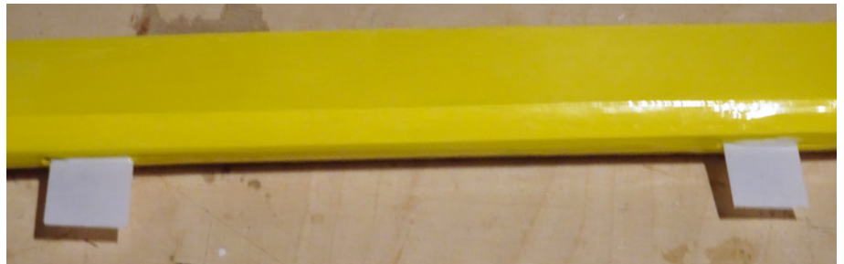
Die beiliegenden Scharnierstreifen sind ideal für Wasserflugmodelle, da sie sich sicher einkleben lassen und bei Wasserkontakt nicht schwergängig werden können
