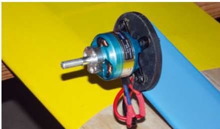
Für die ersten Flüge, bis der Motorsturz perfekt eingestellt ist, dreht der Motor ohne Abdeckung auf dem Pylon frei
