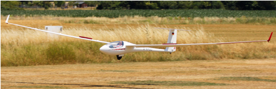
Mit Hilfe der Störklappen und den unterschiedlich einzustellenden Klappen an der Flügelhinterkante sind Landungen kein Problem
