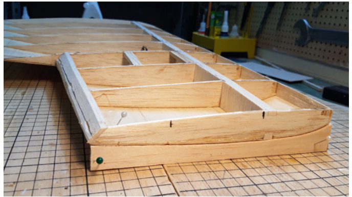
Damit die Montage an den Rumpf problemlos verlaufen kann, wird die Unterseite der Tragflächen zunächst offengelassen
