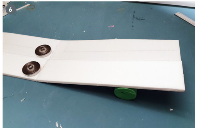
Die Flügelhälften werden mit zirka 12° V-Form zusammengesteckt
