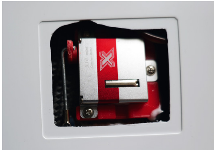
Der Servoeinbau erfolgt ohne Komplikationen
