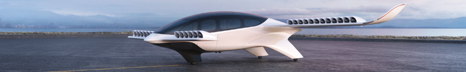
Abbildung 10: Beim Lilium Jet kommt das Schwenkaggregat-Prinzip zum Tragen – an solchen Luft-Taxis wird vielfach geforscht
