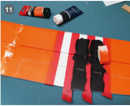
11 Gutes Maskierungsband, Acrylfarbe aus der Tube und ein Schmutzradiererschwamm sind die Mittel der Wahl zur farblichen Gestaltung des Buschtrottel Agro
