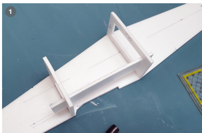
Der Rumpfbau beginnt in Seitenlage. Die Spanten F2 und F3 werden auf eine Seitenwand geklebt
