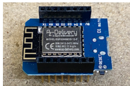
Zentral ist der Mikrocontroller ESP8266 mit WLAN (Antenne auf der Platine sichtbar)
