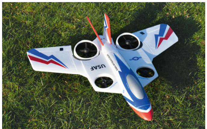
Abbildung 7: Beim Modell FV-31 Cypher von Lindinger werden die hinteren beiden Motorgondeln verschwenkt
