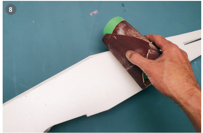
Auch die Rumpfkanten lassen sich schleifen, was eine gefälligere Optik ergibt
