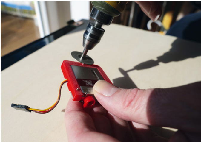
Die Servoschrauben müssen vor dem Einbau gekürzt werden
