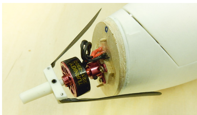
Den Motor habe ich abnehmbar gestaltet. Die elektrische Verbindung stellt sich bei der Montage automatisch her und die Einheit wird über einen Magnet gehalten, der auch die Seglernase sichert
