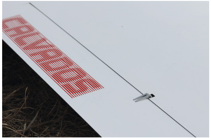
Die von Baudis entwickelten IDS-Anlenkungen sorgen für optimale Wegeverhältnisse bei der Ansteuerung der Ruder und sind aerodynamisch unauffällig
