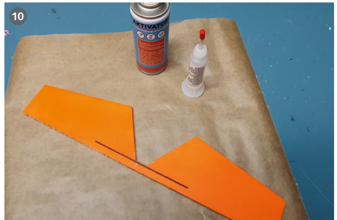
Ein Kohlefaser-Flachprofil verhindert, dass sich die Höhenrudershälften im Flug gegeneinander verdrehen
