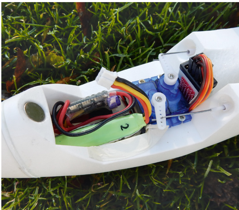
Während die Motorversion einen dreizelligen Akku benötigt, kommt die Seglerversion mit nur zwei Zellen aus, die natürlich so weit wie möglich vorne installiert werden
