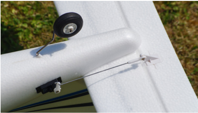
Mitlenkendes Spornrad und direkte Ansteuerung des Höhenruders
