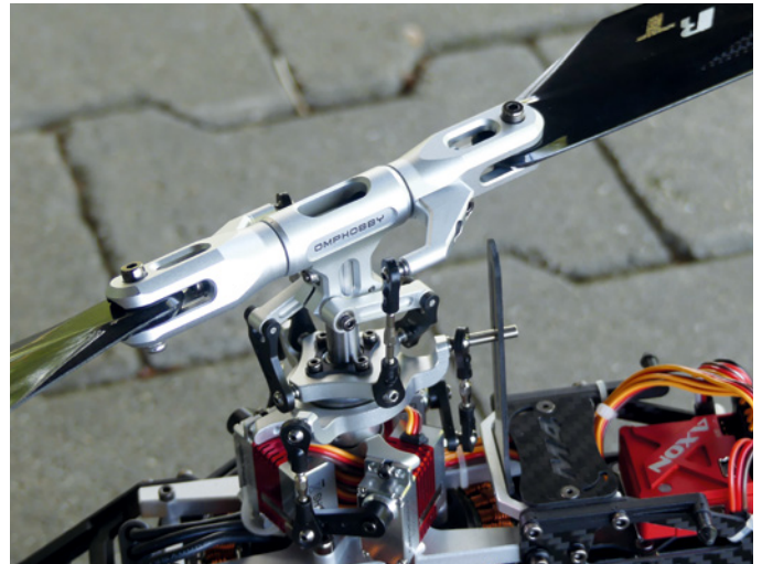
Der Rotorkopf besteht größtenteils aus Aluminium, ist ausgesprochen robust und präzise aufgebaut
