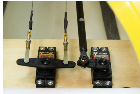
Die beiden Servos für Höhen- und Seitenruder werden direkt hinter der Steckung eingebaut
