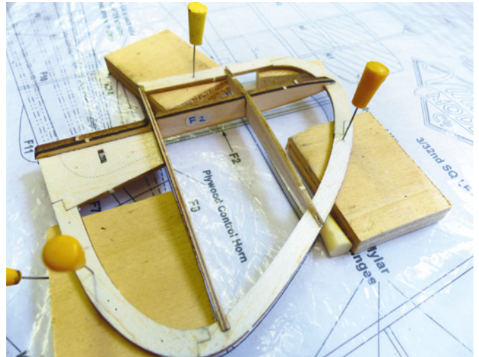
Auf diese Weise unterlegt sollte der Aufbau des Seitenruders problemlos funktionieren
