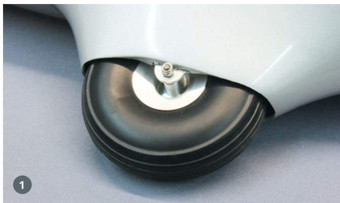
Das Hauptrad ist mit zwei kräftig dimensionierten Alulaschen gelagert, was für eine gute Krafteinleitung in die Rumpfstruktur sorgt
