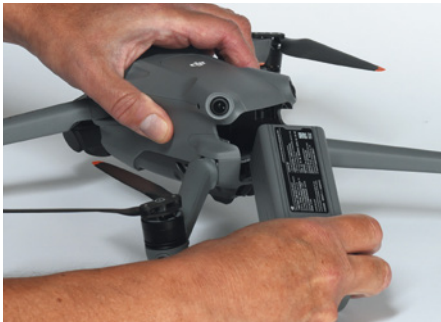
Typisch DJI: Jeder Akku hat seine eigene Bauform und ist nicht kompatibel zu anderen Drohnen. Dafür gestattet der neue 46 Minuten Flugzeit
