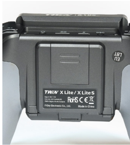
Hinter der rückseitigen Klappe verbirgt sich eine Schnittstelle zum Verbinden externer Module
