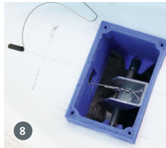
7) Wenn man das Haupttrad demontiert, kann der Kasten mit dem Rumpf verklebt werden. 8) Und so sieht der Radbrems-Kasten im eingebauten Zustand aus. Die Litze wird durch einen Schlitz in der Abdeckung nach vorne zum Servo geführt
