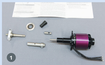
1) Das FesEx System wird mit einem Motor Hacker A50 Glider kombiniert. Hier im Bild die verschiedenen Einzelkomponenten. 2) Erst einmal werden alle Einzelteile „trocken“ zusammengesteckt. Die Rasthülse wird über den Wellenadapter mit dem Motor verbunden. Ganz vorne wird die Rasthülse mit dem Kugellager abgestützt. Der Rastbolzen mit dem Luftschraubenmitnehmer ist hier ebenfalls montiert
