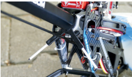
Der Graupner-Satellit wurde unten ins Chassis geklebt, der Antennenhalter vom Autor am CAD gezeichnet und gedruckt
