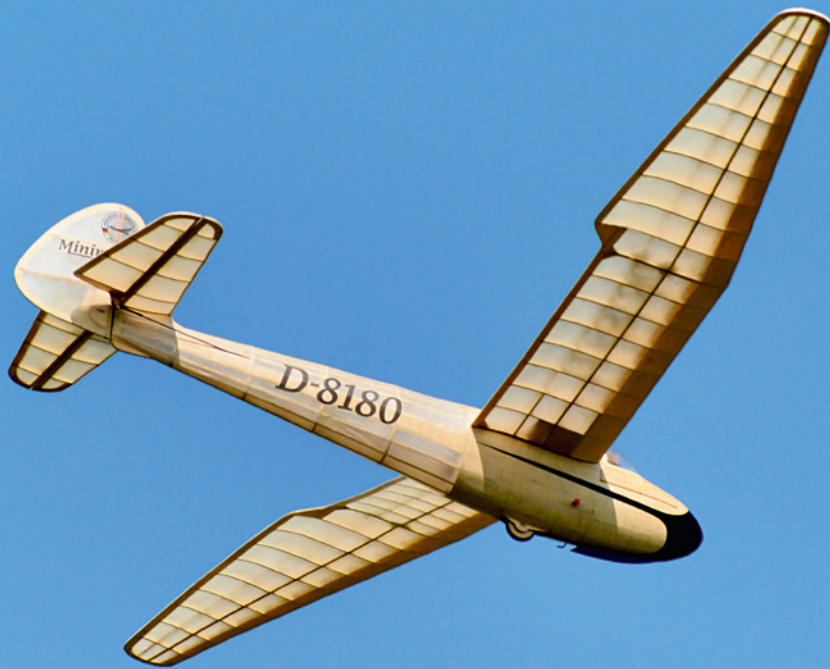
Die Leichtigkeit dieser Minimoa in Balsaholz-Bauweise und Papierbespannung ist auch optisch erkennbar
