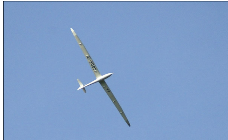
Abbildung 4: Der Ventus 2c hat eine sehr hohe Streckung und damit wird er nur sehr gering vom Randwirbelproblem betroffen
