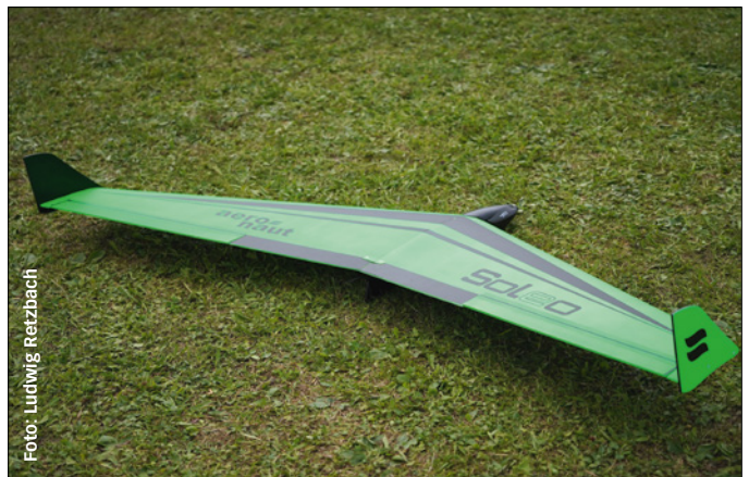
Abbildung 8: Die seitlichen Flossen bei Nurflüglern sind keine Winglets, sondern Seitenleitwerke. Sie bewirken keine Verringerung des Widerstands
