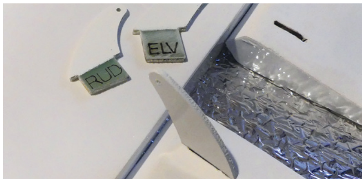
Bei der Montage der perfekt vorbereiteten und beschrifteten Ruderhebel in die exakt passende Aufnahme kann man eigentlich nichts falsch machen
