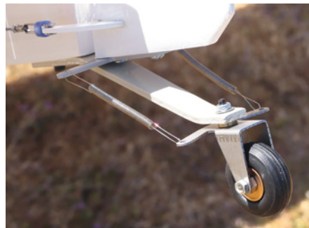
Das robuste Spornfahrwerk mit Anlenkung, Federn und Rad wird montagefertig geliefert; sogar die Einschlagmutter im Rumpf sind bereits montiert
