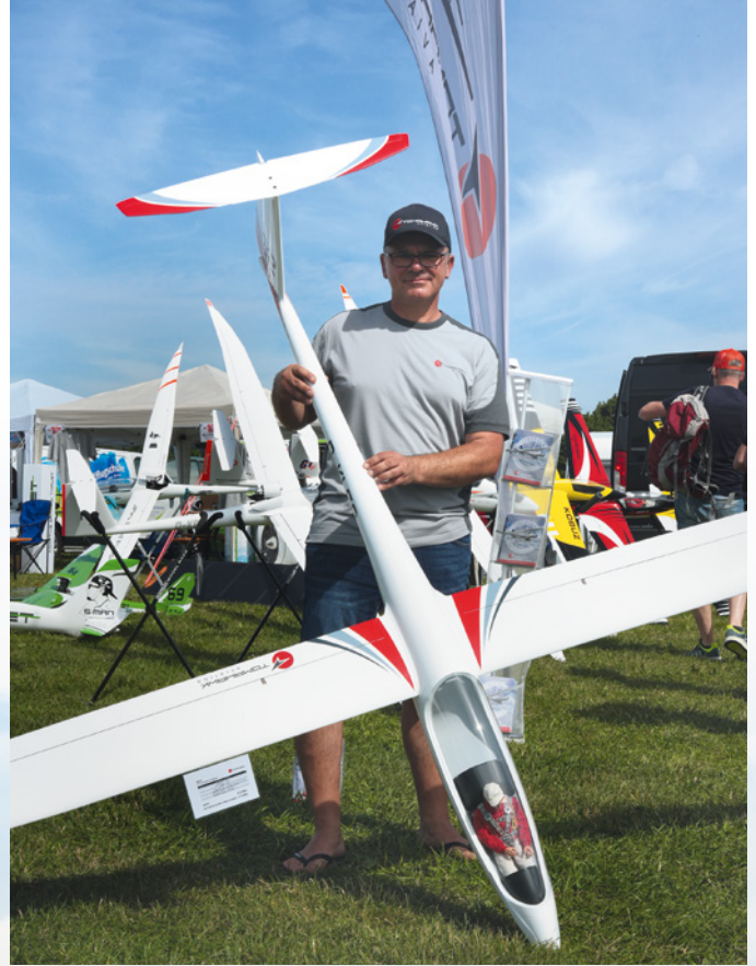
Kurz vor Messebeginn launchte Tomahawk Aviation erste Infos zur neuen ASG-32, die Geschäftsführer Jürgen Friedel hier zeigt. Mit 4.440 mm Spannweite passte der Voll-GFK/CFK-Segler nicht mehr ganz aufs Bild. Erhältlich ist der Doppelsitzer für 2.599,- Euro und für den Einbau eines FES oder Impeller-Antriebs geeignet ( www.tomahawk-aviation.com )
