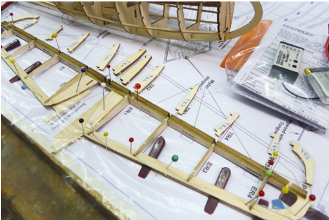
Kleine Keile aus dem Fliesenlegerbedarf waren mir eine wertvolle Hilfe, nicht nur beim Bau des Höhenruders
