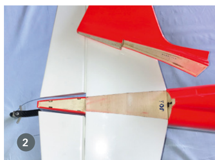
1) Der Akku sitzt auf einem Sperrholzbrettchen und ist über Klettbandschlaufen gesichert. Das Akkubrett wiederum wird vorne in eine Lasche gesteckt und im gut zugänglichen Bereich über zwei M4-Schrauben befestigt. 2) Das Höhenleitwerk und das Seitenleitwerk müssen noch mit dem Rumpf verklebt werden. Dafür ist zuvor die Bügelfolie an den Klebeflächen zu entfernen. 3) Jede Ruderklappe des Höhenruders wird über ein separates Servo angesteuert. Das Seitenruder wurde auf Pull-Pull geändert
