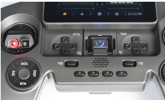
Unter dem schiebbaren Display ist der Ein-aus-Schalter. Die vier Tasten unten sind freie belegbare Geber
