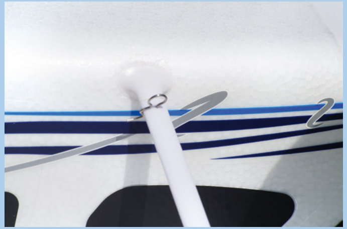
Die Flächenstreben werden rumpfseitig mit Splinten gesichert. Das erleichtert den Abbau zum Transport
