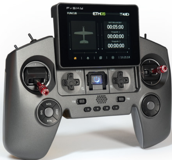
Pfiffiges und praktisches Detail ist das schiebbare Display, das sich auch bei Sonnenlicht gut ablesen lässt
