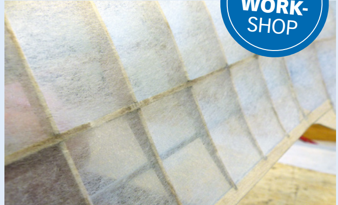
Die konkaven Flügelunterseiten werden zuerst bespannt. Sollte sich das Papier etwas von den Rippen abheben, lässt sich das von der Innenseite her mit etwas verdünntem Uhu Hart beheben
