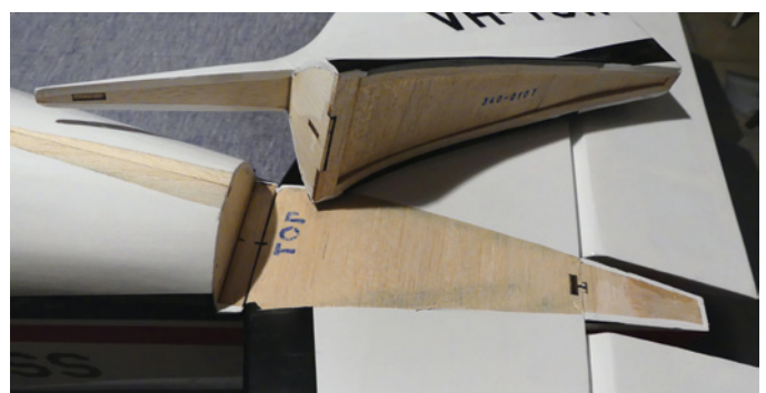
Die Klebeflächen von Höhen- und Seitenleitwerk müssen vor der Montage mit einem scharfen Messer von der Folie befreit werden
