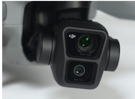
Das neue Doppelkamerasystem mit Weitwinkel- und Tele-Linse im sehr gut arbeitenden Gimbal
