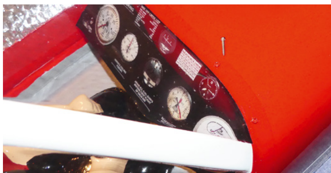
Die Kabinenverglasung soll laut Beschreibung geklebt werden. Beim Testmodell wurden stattdessen 1-mm-Minischrauben verwendet
