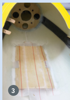
3) Beim Ausrichten leistet ein Kreuzlinien-Laser gute Dienste. Eine gerade, lange Leiste würde sich aber auch eignen. 4) Der Ringspant zur Rückwandmontage des Motors fertig verklebt in der Rumpfspitze. Verschraubt wird das Ganze natürlich über die große Rumpfföffnung
