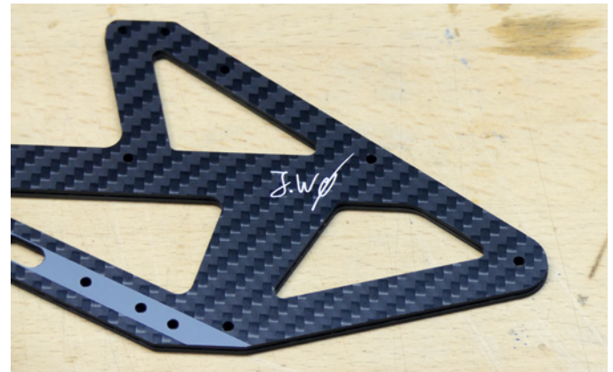
Die 1,5-mm-CFK-Seitenplatten sind sauber gefräst. Ein Entgraten ist hier nicht erforderlich. Nettes Detail an der rechten Platte: die Signatur des Designers Jonas Wackershauser
