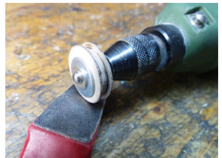
Das aus einzelnen Sperrholzscheiben zusammengeklebte Rad lässt sich in der Bohrmaschine wunderbar rund schleifen
