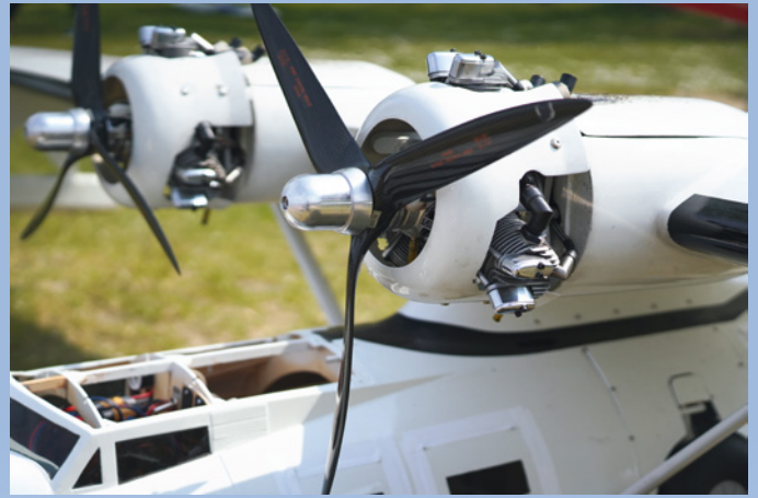
Zwei Dreizylinder von Saito erzeugen 8,6 PS und sorgen für genügend Power zum Abheben
