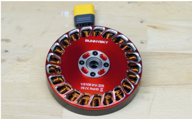
Der große Außenläufer treibt die Rotorwelle direkt an. Er hat 42 Pole und 205 kv. Der Freilauf des Helis sitzt bei dieser Antriebsvariante im Motor. Die Stecker für Akku und Motor sind werkseitig montiert
