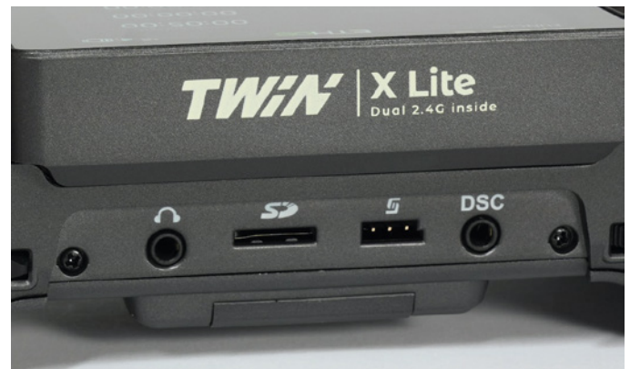
Leicht zugänglicher Mikro-SD-Kartenslot. Praktisch ist der Kopfhörerausgang, zum Beispiel bei Verwendung von Vario- und Telemetrie-Ansagen
