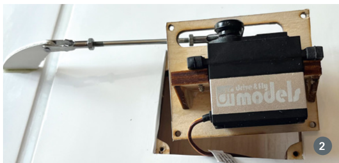
1) Die Position des Motors innerhalb der Motorhaube wird durch Kiefernleisten und Gewindestangen realisiert. 2) Die Servo-Abdeckung aus Sperrholz verfügt bereits über Flansche, auf denen das Servo direkt montiert werden kann. Diese Flansche sind nicht einfach als Klötzchen aufgeklebt, sondern aus solidem Sperrholz im Deckel verzapft
