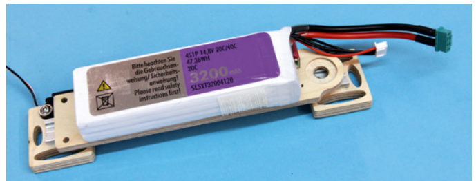
Hier die beiden maximal möglichen Positionen, nämlich ganz vorne oder um 50 mm weiter nach hinten verschoben. Der Verfahrensweg lässt sich gut über den Sender festlegen
