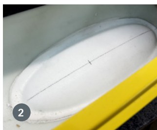
2) Ab Werk ist leider keine Bremse vorgesehen. Daher ist im ersten Schritt eine Mittellinie auf der Radabdeckung anzuzeichnen. 3) Gleich darauf erfolgt das Anzeichnen des Ausschnitts und die Trennscheibe wird angesetzt
