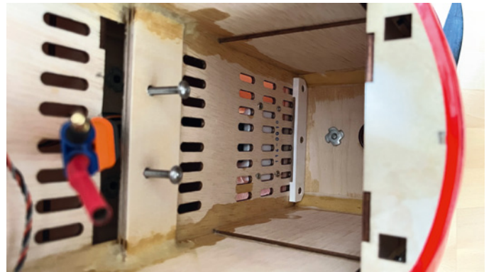
Blick nach vorne Richtung Kopfspant, dort ist ein 3D-Druck-Teil (weiß) zur Fixierung des Akkubretts montiert
