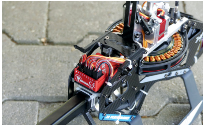
Der Einbauraum für Stabi und Empfänger ist nicht üppig, aber ausreichend. Hier erkennt man auch gut die seitlich aufgeschraubten Haubenhalter aus Kunststoff
