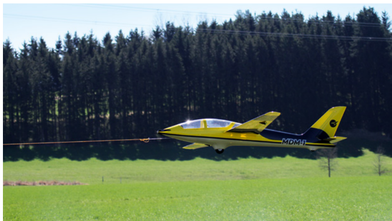
Im F-Schlepp braucht das Testmodell nur sehr wenige Steuereingaben, um der Schleppmaschine zu folgen
