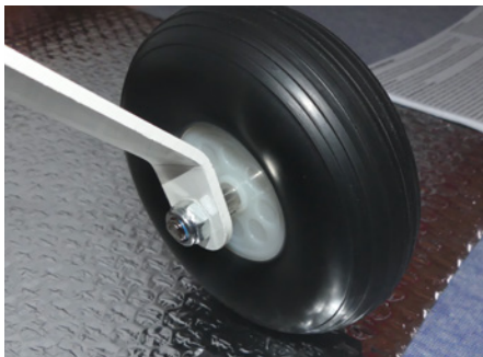
Das stabile Alu-Hauptfahrwerk ist weiß lackiert. Die Radachsen samt der hochwertigen 115-mm-Räder gehören zum Lieferumfang
