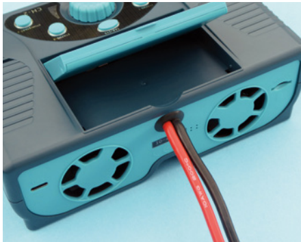
Das rückseitige Kabel wird mit der Spannungsquelle verbunden, außerdem befinden sich dort der USB-Port und der SD-Karten Slot sowie zwei Lüfter
