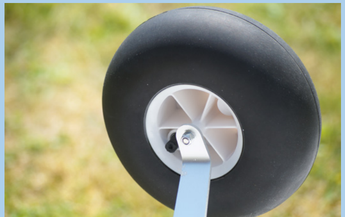
Die 120-mm-Lufträder sind ein wesentliches Merkmal des Modells. Über das schwarze Ventil kann man den Luftdruck regeln
