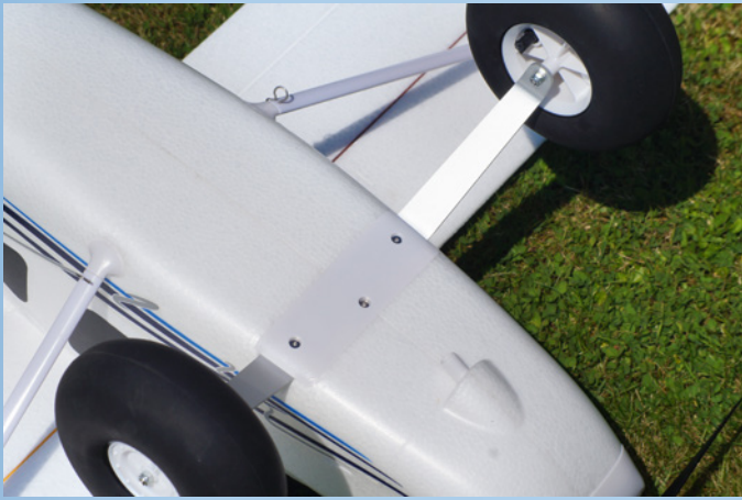
Der Fahrwerkseinbau ist perfekt gelöst und die drei Schrauben reichen zur Sicherung des Alubügels
