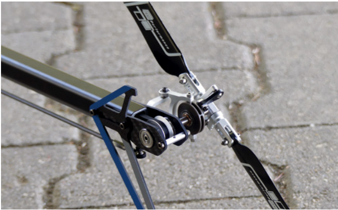
Der spielfreie Heckrotor des M4. Durch die engen Toleranzen ist bei seiner Montage mit Gefühl vorzugehen, sodass alles schön leicht läuft
