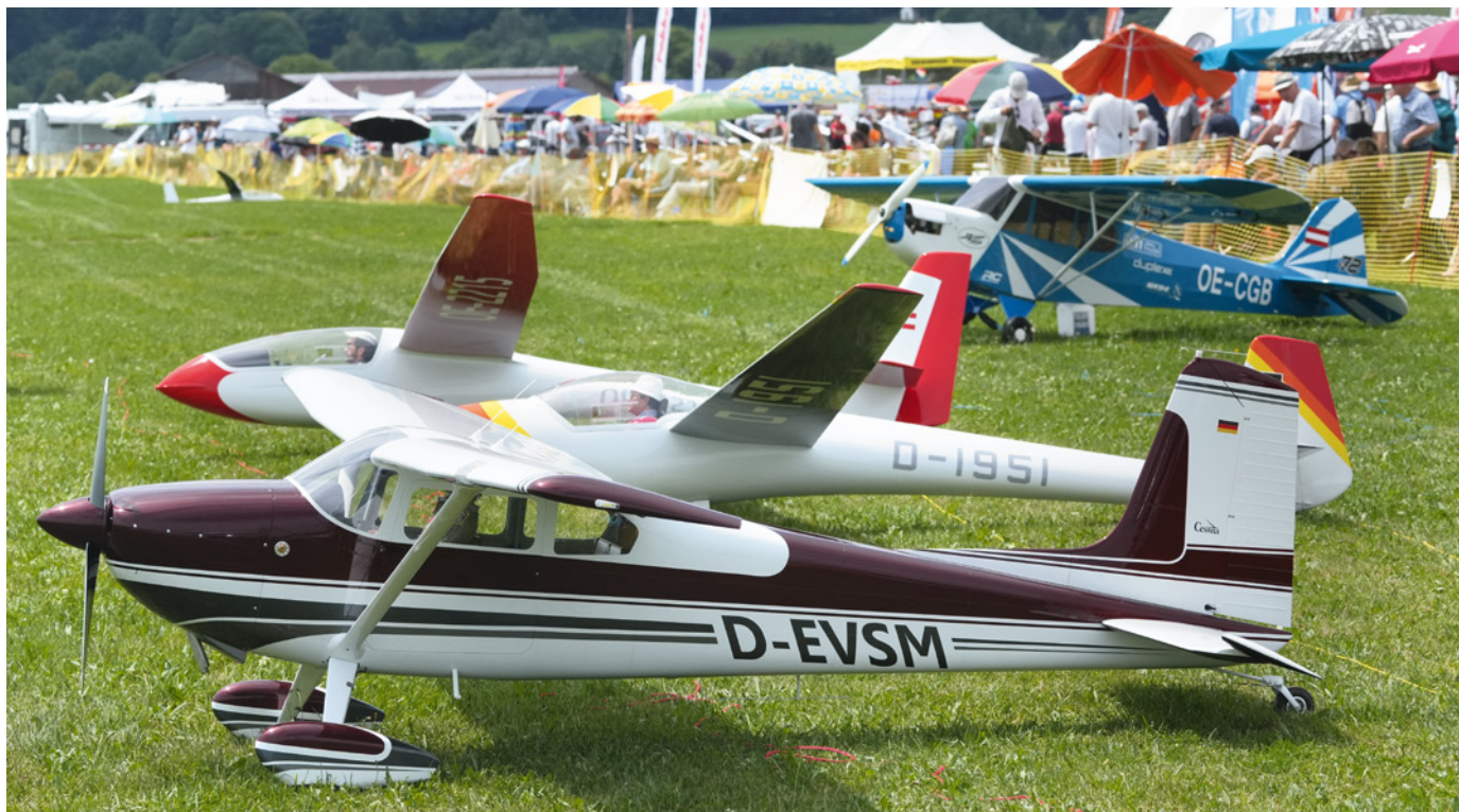
Mit 4.000 mm Spannweite und 21 kg Gewicht ist die im Vordergrund stehende Cessna 180 von Bruckmann ein echtes Arbeitstier unter den Schleppern ( www.modellbau-bruckmann.at )
