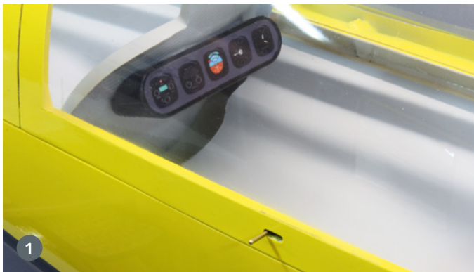
1) Der deutlich überstehende Hebel, um die Haube zu öffnen, wurde nachträglich gekürzt. Das hintere Instrumentenbrett ist mit der vorderen Sitzschale verbunden. 2) Die Lagerung für die beiden Leitwerke hat der Hersteller ebenfalls bestmöglich vorbereitet
