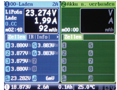
Beim Laden werden die wichtigsten Parameter übersichtlich visualisiert, beispielsweise die Anzeige der Innenwiderstände
