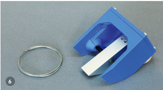
6 Die CFK-Achse wird in Halbschalen zwischen den beiden Druckteilen gehalten, so ist die Bremse später jederzeit wieder demontierbar. Die Stahlitze zur Anlenkung liegt schon bereit
