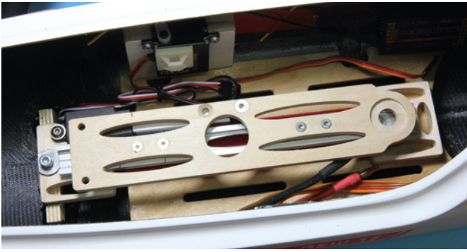
Das System wurde oberhalb der bisherigen Akkubefestigung montiert
