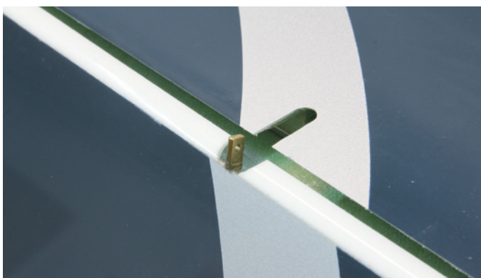
Über diese Augschrauben werden die Wölbklappen auf der Flügeloberseite angelenkt. Gut zu sehen sind die GFK-Dichtlippen
