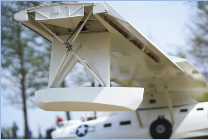
Wie beim Original lassen sich die Schwimmer in die Tragflächenenden schwenken
