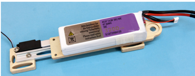
Hier die beiden maximal möglichen Positionen, nämlich ganz vorne oder um 50 mm weiter nach hinten verschoben. Der Verfahrensweg lässt sich gut über den Sender festlegen
