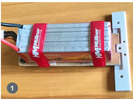
1) Der Akku sitzt auf einem Sperrholzbrettchen und ist über Klettbandschlaufen gesichert. Das Akkubrett wiederum wird vorne in eine Lasche gesteckt und im gut zugänglichen Bereich über zwei M4-Schrauben befestigt. 2) Das Höhenleitwerk und das Seitenleitwerk müssen noch mit dem Rumpf verklebt werden. Dafür ist zuvor die Bügelfolie an den Klebeflächen zu entfernen. 3) Jede Ruderklappe des Höhenruders wird über ein separates Servo angesteuert. Das Seitenruder wurde auf Pull-Pull geändert
