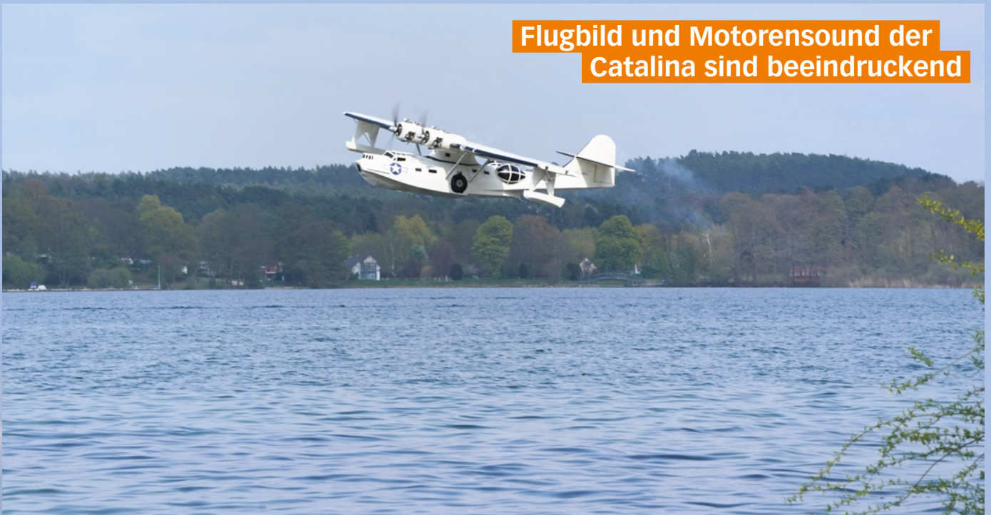
Wie beim Original lassen sich die Schwimmer in die Tragflächenenden schwenken
