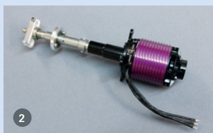
1) Das FesEx System wird mit einem Motor Hacker A50 Glider kombiniert. Hier im Bild die verschiedenen Einzelkomponenten. 2) Erst einmal werden alle Einzelteile „trocken“ zusammengesteckt. Die Rasthülse wird über den Wellenadapter mit dem Motor verbunden. Ganz vorne wird die Rasthülse mit dem Kugellager abgestützt. Der Rastbolzen mit dem Luftschraubenmitnehmer ist hier ebenfalls montiert
