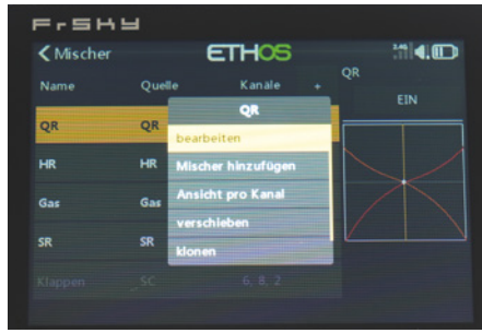
Nach dem Anklicken des Kanals öffnet sich ein Dropdown-Menü zur weiteren Bearbeitung des Kanals oder Mixers
