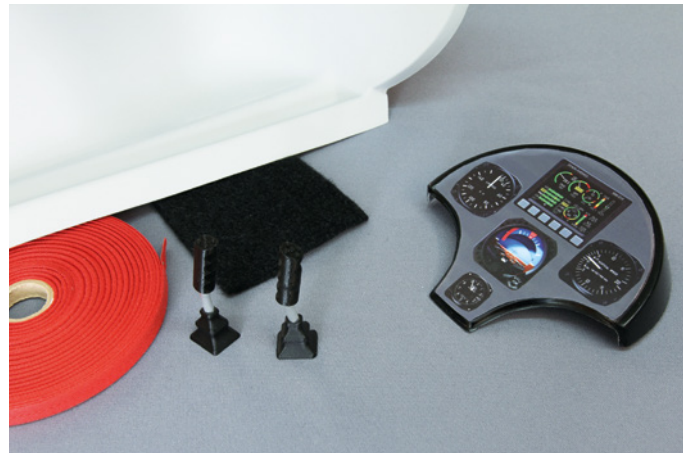
Mit Teilen aus dem 3D-Drucker, etwas Alurohr, Nahtband und Filz lässt sich der Cockpitausbau für wenig Geld realisieren
