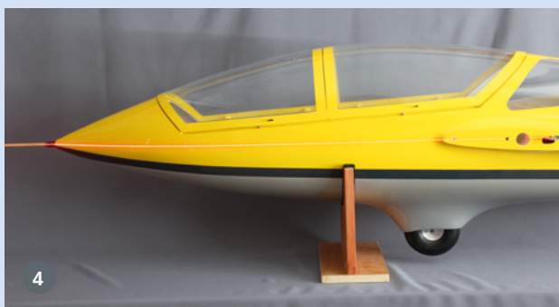
3) Beim Ausrichten leistet ein Kreuzlinien-Laser gute Dienste. Eine gerade, lange Leiste würde sich aber auch eignen. 4) Der Ringspant zur Rückwandmontage des Motors fertig verklebt in der Rumpfspitze. Verschraubt wird das Ganze natürlich über die große Rumpfföffnung
