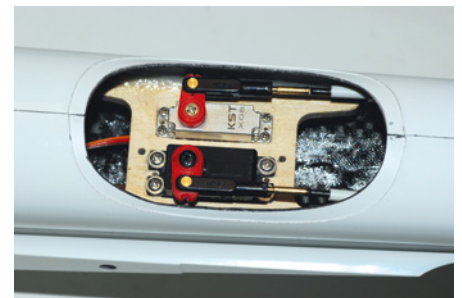
Die Leitwerksservos hängen kopfüber im hinteren Bereich der Tragfläche
