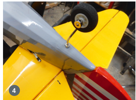
1) Die stabilen Federbeine mit Gasdruckfeder werden in Gewindestücke eingeschraubt, die im Rumpf eingelassen sind. 2) Mit stromlinienförmigen Verkleidungen und tiefgezogenen Rumpfübergängen lassen sich die Fahrwerksbeine ansprechend umsetzen. 3) Beide Leitwerke passen saugend in die Aussparungen am Rumpf und werden mit Epoxy verklebt. 4) Das robuste Spornrad wird vom Seitenleitwerk mitgelenkt
