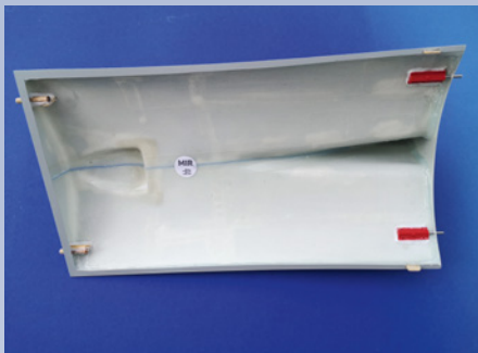
Der Deckel der Montageöffnung für die Turbine von innen, hier bereits mit Dübeln und Verschlüssen ausgestattet
