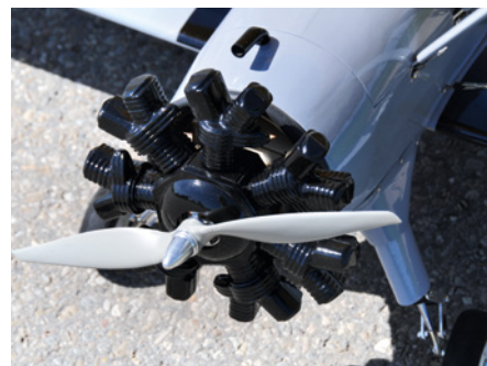
Sind Motor, Attrappe und Träger platziert, kann alles im Rumpf verklebt werden
