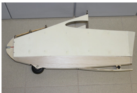
Die Herausforderung beim Rumpfbau ist, dass die großen Seitenteile etwas zu biegen sind
