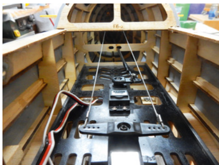
Die Servos sitzen hintereinander im Rumpf, das Höhenruder wird über eine Schubstange und das Seitenruder mittels Stahllitzen angesteuert
