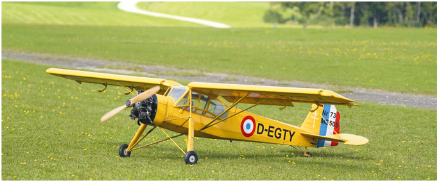
Abbildung 2: Die MS-505 (Lizenzbau des Fieseler Storch) folgt dem Prinzip des Zweibein-Fahrwerks. Das kleinere Spornrad ist zum Lenken mit dem Seitenleitwerk gekoppelt
