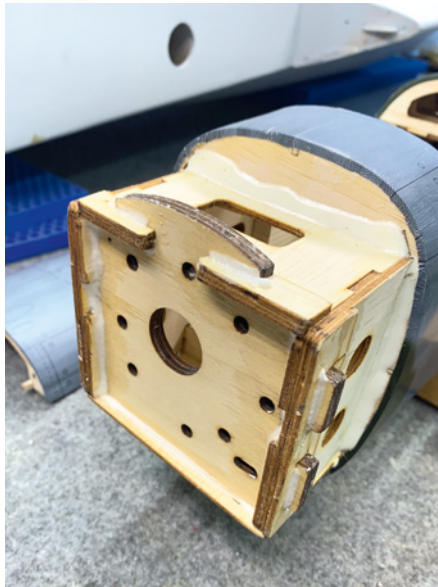
Zur Motormontage ist zwar bereits ein Holzdom angebracht, aber die Dimensionen reichen noch nicht
