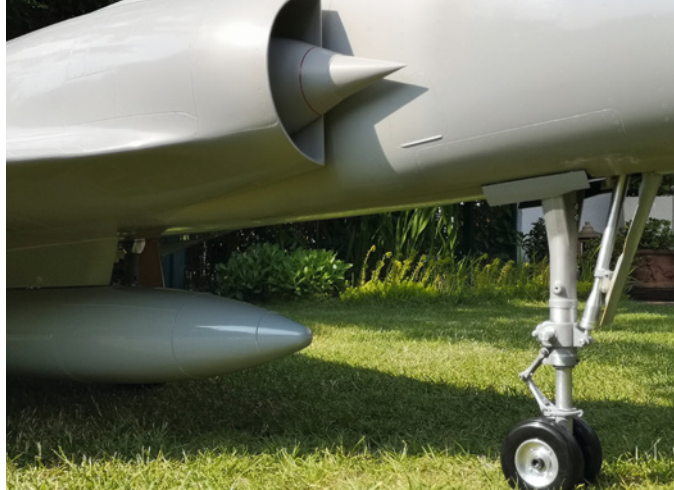
Das fertig montierte Bugfahrwerk mit geschlossener Tür und Abdeckungen. Hier ist auch der Center-Tank montiert und man kann gut erkennen, wie spitz die Einlasskonen sind
