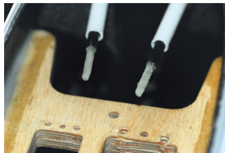
Die Bowdenzüge zu den Leitwerken sind nicht aus CFK, sondern aus GFK mit einer Teflon-Umhüllung, welche im Klebebereich unbedingt entfernt werden muss
