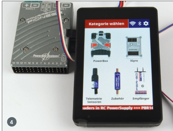
3) Die Schnittstellen für SD-Karte, Data-Anschluss und USB beim Mobile Terminal sind zum Schutz etwas zurückgesetzt. 4) Über den Menüpunkt Kategorie lassen sich die Produkte von PowerBox finden und auswählen
