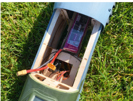
Im Rumpf wäre Platz für größere, schwerere Akkus, aber auch das 4s-Setup funktioniert und sorgt für ein niedriges Abfluggewicht
