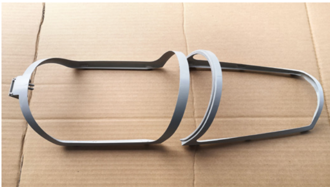
Der zweiteilige Kabinenhaubenrahmen ist ausgeschnitten und zur Lackierung vorbereitet
