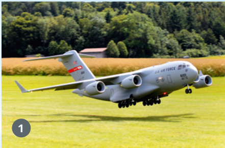
1) Die majestätische Globemaster abheben und fliegen zu sehen, ist unbestritten ein eindrucksvolles Erlebnis. 2) Die Fluggeschwindigkeit und der Sound der vier E-Impeller sind verblüffend vorbildgetreu. Die Aufsetzgeschwindigkeit des 150-kg-Giganten liegt laut Telemetrieansage bei etwa 50 bis 55 km/h. 3) Vier 195-mm-Impeller von Schübeler (Motor DSM10066-290) leisten je etwa 25 kg/15 kW Schub. Die vier 400-A-Regler werden jeweils von 14s-LiPos mit 17.000 mAh Kapazität gespeist
