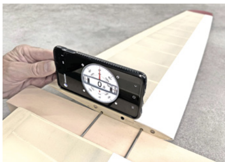
Die Winkelmesser-App wird nun an der Wurzelrippe auf 0° kalibriert. Dort und bei Rippe 1 ist die EWD des Flügels ja per Definition korrekt, weil hier der Flügel am Rumpf aufliegt. Aber wie sieht es wohl im weiteren Verlauf der Spannweite aus?
