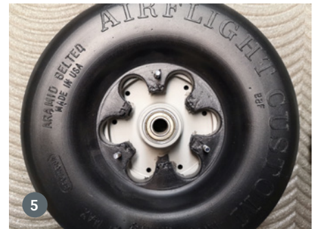
4) Die Alu-Felgen des Hauptfahrwerks bestehen aus zwei Halbschalen und sind kugelgelagert. Die Optik kommt dem Original sehr nah. 5) Vor dem Zusammenbau der Räder müssen die Reifengummis an drei Stellen durchbohrt werden
