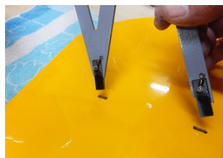
Die N-Streben, die den oberen und unteren Flügel miteinander verbinden, sind mit CFK-Laschen mit den Flügeln verklebt
