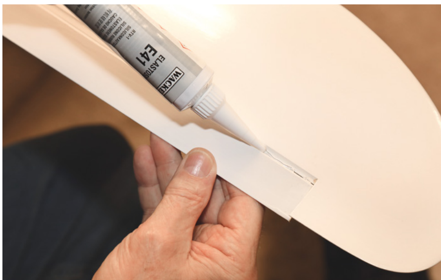
Einfach eine Silikonraupe auftragen – mehr ist nicht erforderlich
