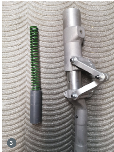
3) Ein Bein des Hauptfahrwerks. Die Feder war in Kombination mit dem Distanzstab deutlich zu hart abgestimmt und wurde durch eine Kombination aus einer weichen und einer harten Feder ersetzt
