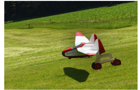
In der Fauvel ist eine Schleppkupplung verbaut. Der Startwagen hilft sehr. Eigenstart mit Motor ist aber auch machbar
