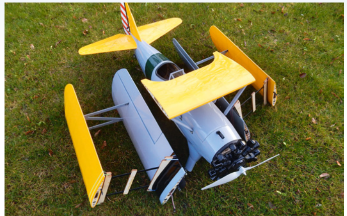
Zum Transport kann das Tragwerk komplett abgenommen werden, wobei die beiliegende Sperrholz-Hilfsstütze bei Montage, Demontage und Transport sehr hilfreich ist
