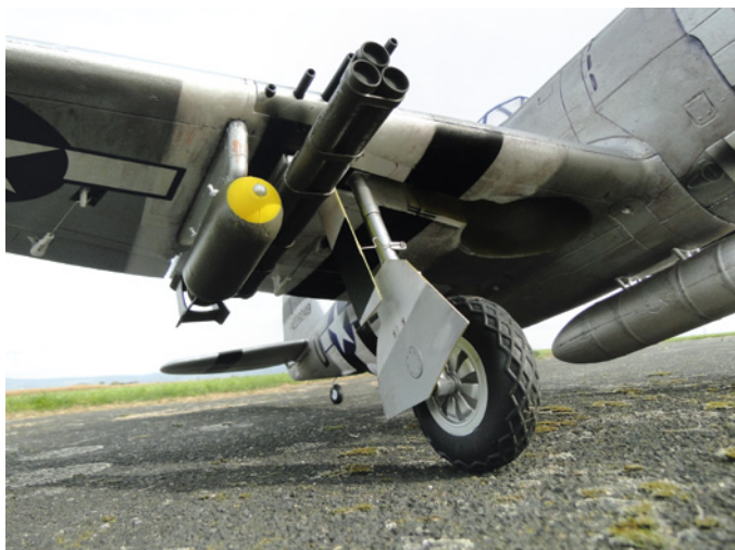
Das „Federbein“ ist nur eine Plastikverkleidung, aber die großen Räder dämpfen die Landestöße ausreichend ab
