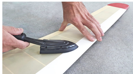
Durch Überbiegen mit der einen und Nachbügeln mit der anderen Hand ziehen wir bereichsweise die unliebsame Verdrehung aus der Tragfläche, stets von innen nach außen
