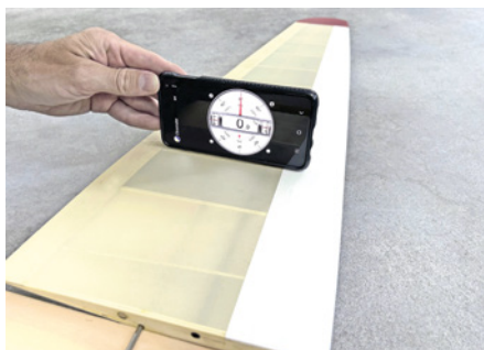
Tatsächlich, hier haben wir schon eine erste Abweichung. Durch Anlegen der Wasserwaage an jeder Rippe lässt sich zunächst einmal der gesamte Flügel in Ruhe analysieren, damit wir später wissen, was zu tun ist
