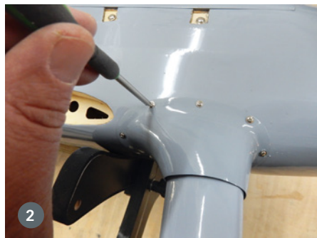
1) Die stabilen Federbeine mit Gasdruckfeder werden in Gewindestücke eingeschraubt, die im Rumpf eingelassen sind. 2) Mit stromlinienförmigen Verkleidungen und tiefgezogenen Rumpfübergängen lassen sich die Fahrwerksbeine ansprechend umsetzen. 3) Beide Leitwerke passen saugend in die Aussparungen am Rumpf und werden mit Epoxy verklebt. 4) Das robuste Spornrad wird vom Seitenleitwerk mitgelenkt
