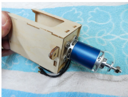
Pfiffig gemacht ist die Motorhalterung, die außerhalb vom Rumpf mit dem Motor und dem Regler sowie der Motoratruppe bestückt wird
