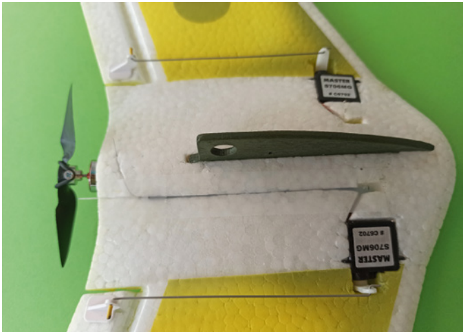
Die soliden Metallgetriebe-Servos steuern die Elevons von unten an
