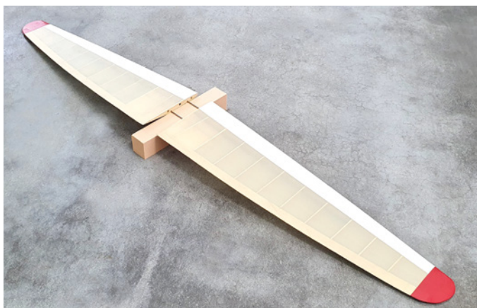
Der Flügel wird auf den Flächensteckungsdrähten aufgebockt. Der Klotz ist so hoch, dass die Flügelspitzen lastfrei den Boden touchieren – der Flügel soll weder kippln noch aufliegen
