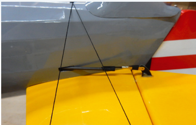
Ganz am Ende erfolgt die Verspannung der Leitwerke und Flügel, die nicht nur gut aussieht, sondern auch Festigkeit bringt
