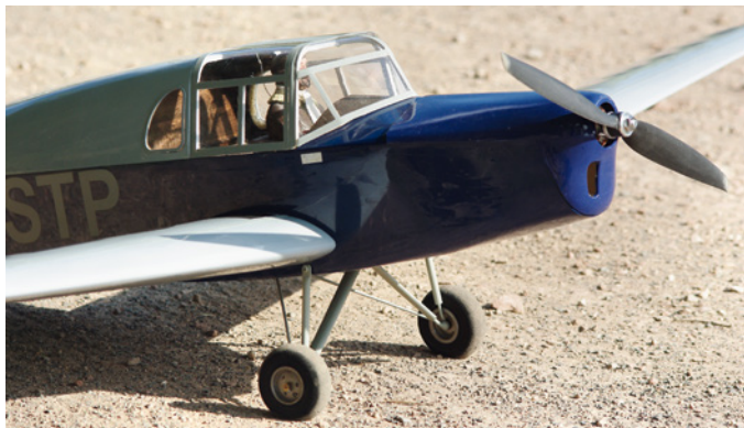
Abbildung 6: Die Siebel 2002 ist ein typisches Muster mit hoch stehender Nase aufgrund des Zweibein-Fahrwerks. Die Sicht des Piloten war dadurch beim Start eingeschränkt.
