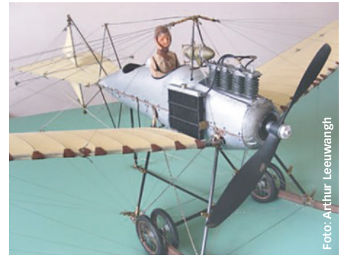
Abbildung 3: Die Fokker Spinne hatte sowohl ein Zweibein-Fahrwerk als auch zusätzliche Sicherheitskufen
