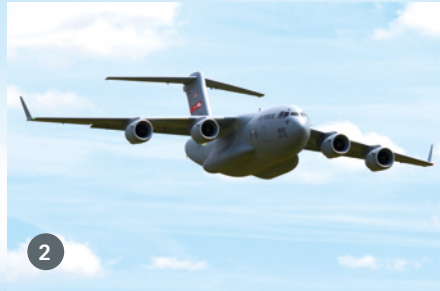
1) Die majestätische Globemaster abheben und fliegen zu sehen, ist unbestritten ein eindrucksvolles Erlebnis. 2) Die Fluggeschwindigkeit und der Sound der vier E-Impeller sind verblüffend vorbildgetreu. Die Aufsetzgeschwindigkeit des 150-kg-Giganten liegt laut Telemetrieansage bei etwa 50 bis 55 km/h. 3) Vier 195-mm-Impeller von Schübeler (Motor DSM10066-290) leisten je etwa 25 kg/15 kW Schub. Die vier 400-A-Regler werden jeweils von 14s-LiPos mit 17.000 mAh Kapazität gespeist
