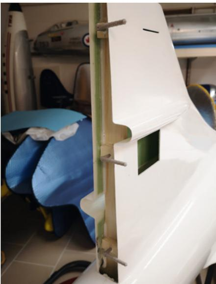
Die Endleiste des Seitenleitwerks ist recht weit vorn eingeharzt, damit noch Platz für Verstärklötzchen zur Aufnahme der Stiftscharniere bleibt. Die originalgetreuen Verkleidungen der Anlenkungen sind an der Dämpfungsfäche bereits nahtlos angeformt, am Ruder müssen sie noch angepasst und aufgeklebt werden
