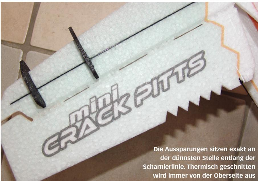
Die Aussparungen sitzen exakt an der dünnsten Stelle entlang der Scharnierlinie. Thermisch geschnitten wird immer von der Oberseite aus
