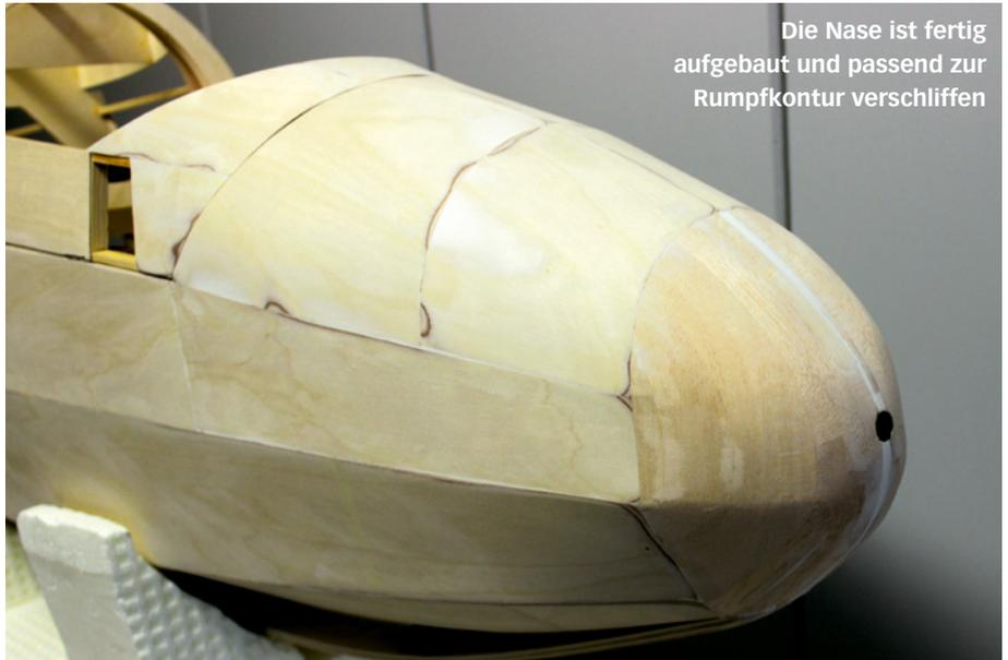
Die Nase ist fertig aufgebaut und passend zur Rumpfkontur verschliffen
