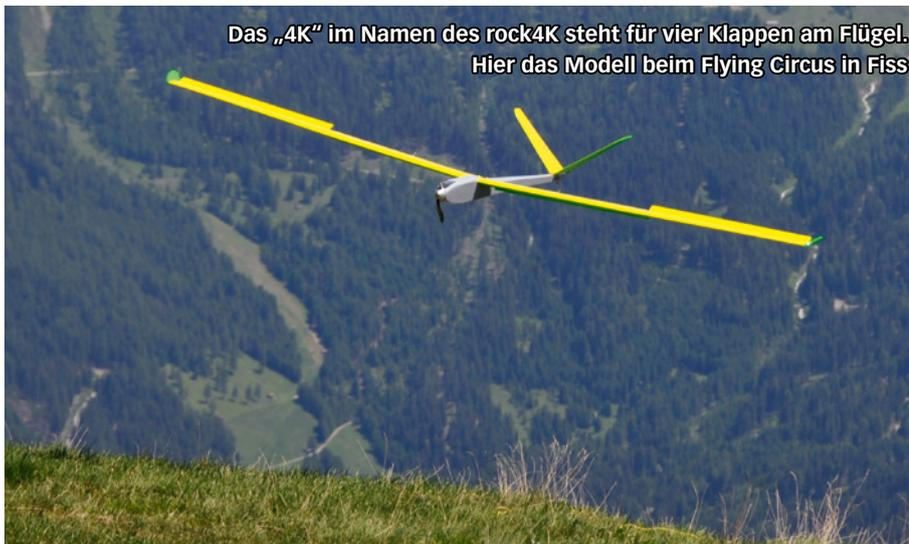
Das „4K“ im Namen des rock4K steht für vier Klappen am Flügel. Hier das Modell beim Flying Circus in Fiss
