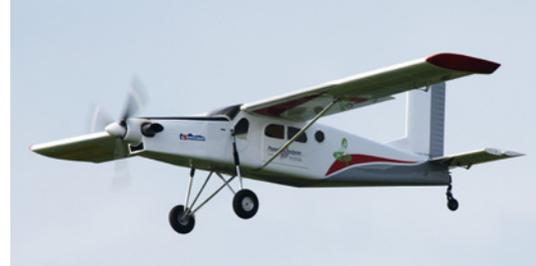
Bei der Vorführung der Pilatus PC-6 Turbo Porter von TS-Modelltechnik war Firmeninhaber Thomas Schulz selbst am Steuer. Das Voll-GFK-Modell hat eine Spannweite von 3,74 m und wiegt 21,16 kg. Die Propeller-Turbine JetCat SPT-5 V3 treibt einen 25 x 10-Zoll-SEP-Holzprop an
