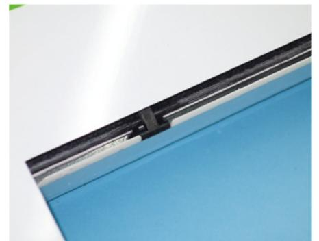
Bei den Wölbklappen muss darauf geachtet werden, dass nahezu 90 Grad Ausschlag nach unten erreicht werden
