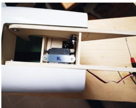
Die modifizierte Version zur Anlenkung der Schwenknase: So kommt das Servo ganz nach vorn und ist gut zugänglich
