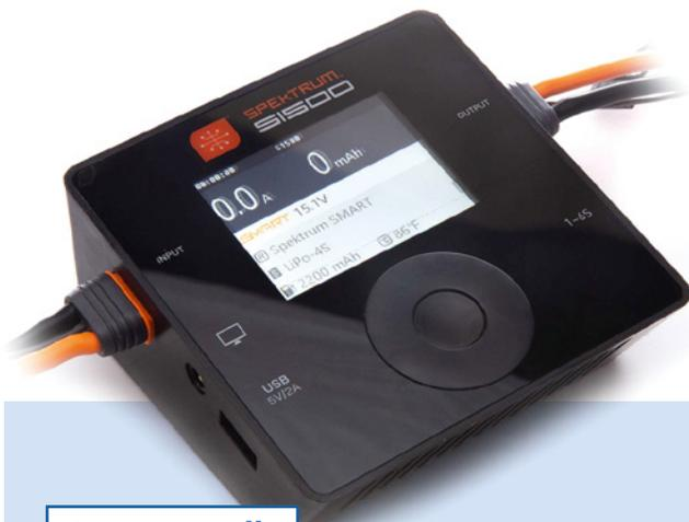
Der große Bruder Spektrum S1500 DC Smart Charger leistet bis 500 W. Die Eingangsspannung kann zwischen 8 und 30 V liegen und es lassen sich 1s- bis 6s-LiHV-, LiPo-, LiFe-, Lilon-Akkus oder bis zu 16-zellige NiMH- und NiCd-Energiespeicher sowie bis zu zwölfzellige Pb-Akkus laden. Der Ladestrom lässt sich von 0,1 bis 20 Ampere in 0,1-Ampere-Schritten einstellen, der Entladestrom liegt zwischen 0,1 und 1,5 Ampere. Der Preis: 139,99 Euro. [www.horizonhobby.eu](http://www.horizonhobby.eu)
