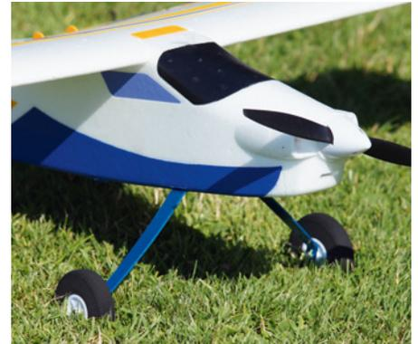
Das stabile Landfahrwerk ist schnell gegen das Paar Schwimmer eingetauscht und der Super EZ Rasenplatz-tauglich
