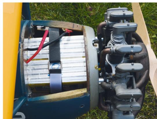
**Der 10s-LiPo mit 5.000 mAh Kapazität sitzt unmittelbar hinter dem Brandschott**
