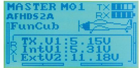
Die Telemetrie-Funktion erlaubt die Überwachung wichtiger Modellparameter
