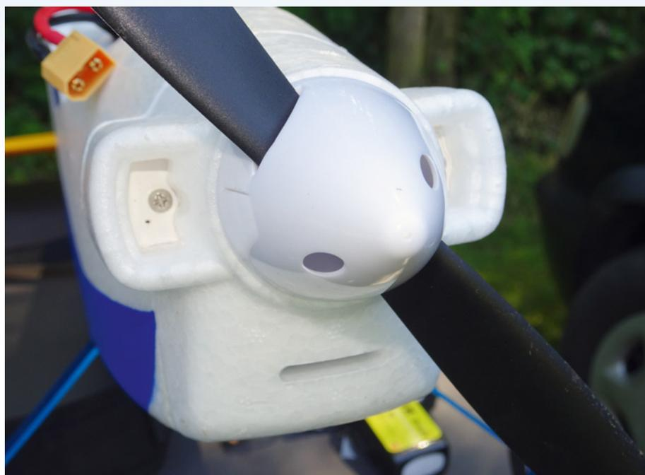
**Die Frontansicht. Durch den kleinen Schlitz unter dem Spinner beziehen der Regler und der Motor etwas Kühlluft. Zum Wasserfliegen sollte man diesen allerdings abkleben**
