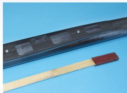
Um die Klebefläche innen im Rumpf anzurauen, bedarf es eines speziellen Hilfsmittels, bestehend aus einer Holzlatte mit vorne aufgeklebtem Sandpapier
