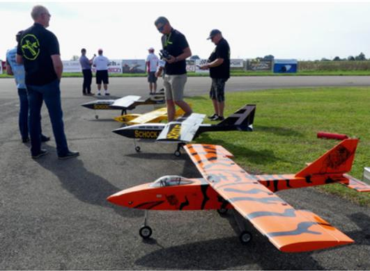
Der Laser- und Frässervice Trost war gleich mit vier Holz-Bausatzmodellen am Start. Die einfach gestalteten Trainer haben Spannweiten von 1,6 m bis 2 m, wiegen zwischen 7 und 12 kg und können mit 50- beziehungsweise 100- bis 140-N-Turbinen betrieben werden
