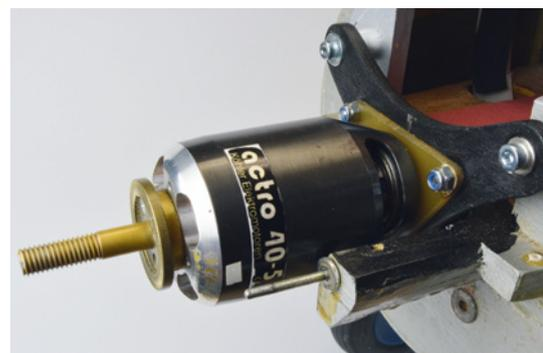
**Der actro 40-5 ist ein sehr leistungsfähiger, kräftiger Elektromotor. Die seitlichen Gewindestäbe dienen zur Befestigung der Sternmotoratruppe**
