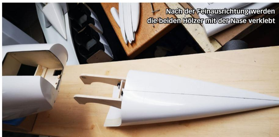
Nach der Feinausrichtung werden die beiden Hölzer mit der Nase verklebt
