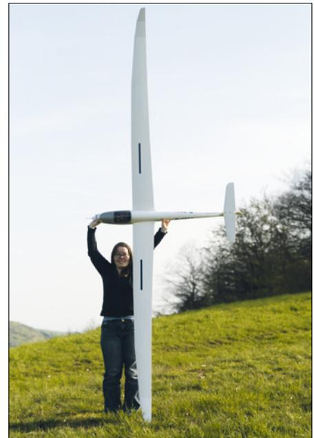
**Abbildung 15:** Die Ventus 2c mit fast 4 m Spannweite hat in den Außenflächen eine derart geringe Profiltiefe, dass sie kaum effizient langsam geflogen werden kann
