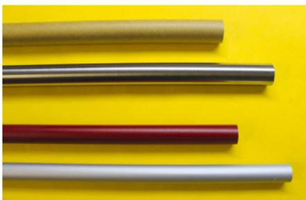
Die Steckung aus VA-Rohr ist in einer Pappröhre und das Alu-Rohr in einer Blechröhre geführt
