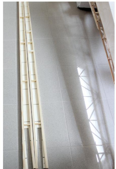
Aufbau der beiden nach genauem Maß zu fertigenden Flügelholme
