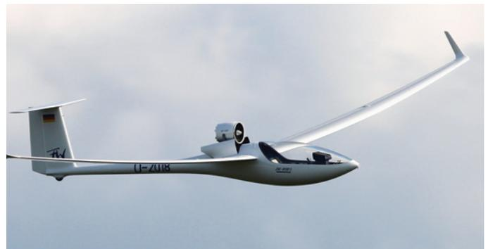
Pascal Heil von FW-Models führte die neue DG808S aus eigener Produktion vor. Der Hochleistungssegler geht mit dem Klapp-E-Impeller Jetec E-120 von Mig-Flight granatenmäßig. Aber auch mit eingefahrenem Triebwerk konnte der Segler überzeugen. Spannweite 6 m und Gewicht 16 kg
