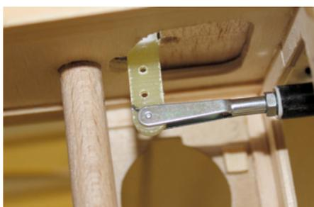
Die Höhenruder-Anlenkung kann man über eine Klappe einhängen – auch nach dem Folieren – was eine komplette Demontage zum Transport ermöglicht
