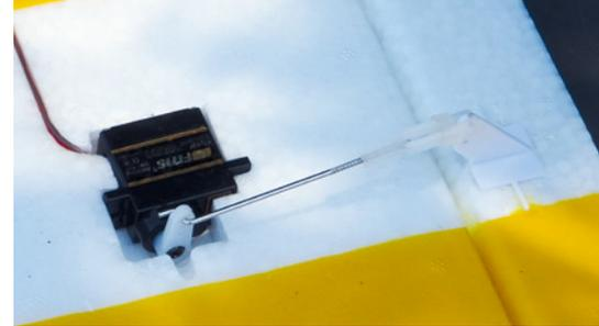
Auch die Querruderanlenkung ist so kurz und direkt wie möglich ausgeführt
