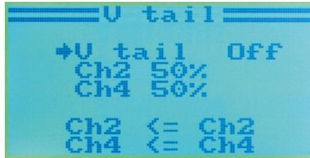
Der implementierte V-Leitwerksmischer gestattet das Steuern besonderer Modelle
