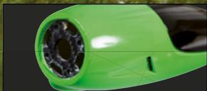
+ eingeharzter Carbon Motorspant
