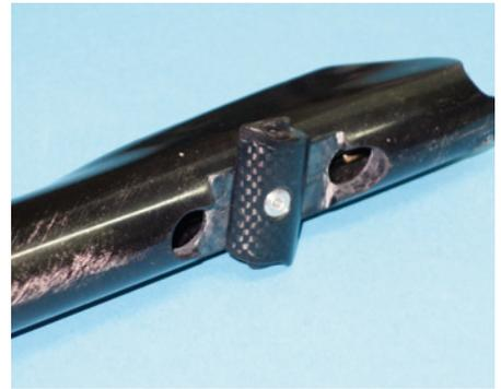
Der Bajonett-Verschluss ist ebenfalls ab Werk fertig eingebaut. Einfach die Leitwerke von oben durchstecken, den Verschluss drehen und diese sind fest am Rumpf fixiert
