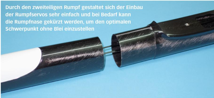
Durch den zweiteiligen Rumpf gestaltet sich der Einbau der Rumpfservos sehr einfach und bei Bedarf kann die Rumpfnase gekürzt werden, um den optimalen Schwerpunkt ohne Blei einzustellen
