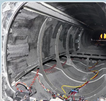
Ein Blick in den Rumpf. Aufgebaut wurden der 7-teilige Rumpf und die 3-teiligen Tragflügel komplett in CFK-Aramid-Sandwich-Wabe
