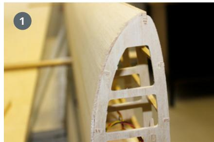
hier steckt noch ein Rumpfbrett zirka 13 mm über der unteren Kulisse in den Spanten – quasi parallel zum Baubrett. Spant 6 ist ein Doppelspant, der nicht in der Kulisse steckt, weil da der Radkasten ist. Zu diesem Zeitpunkt sollte man auch schon mal die Rumpfabchlussrippe einsetzen, jedoch noch nicht festkleben. Es geht also nur langsam Spant für Spant voran – und immer auf den Rechten Winkel achten!
