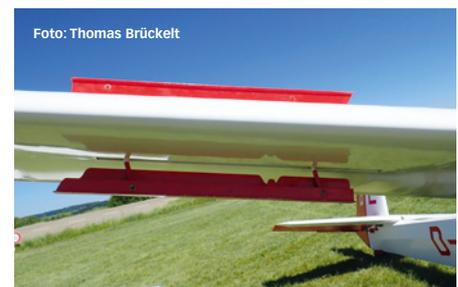
**Die Schempp-Hirth-Bremsklappen fahren nach oben und unten aus**
