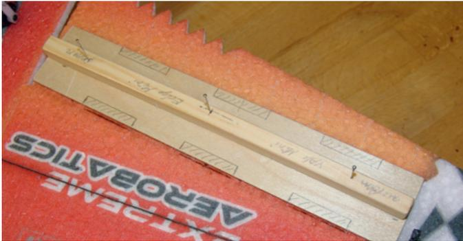
Die Führungsleisten werden mit Stecknadeln auf den Schaumplatten entlang der Scharnierlinie fixiert. Dann kann während des Schneidens nichts verrutschen
