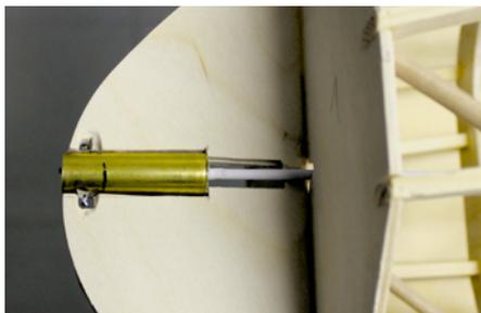
In der Nase der K-8B ist eine Schleppkupplung verbaut. Hier ein Blick darauf, bevor sie eingebaut ist
