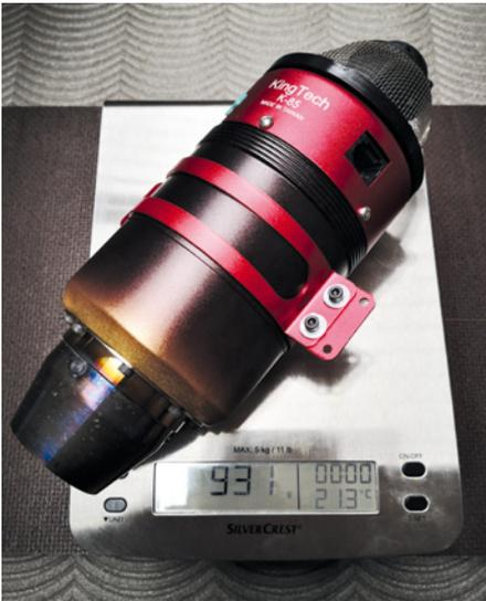
**Nach dem Auspacken kam die Turbine erstmal auf die Waage, die Gewichtsangabe des Herstellers passt. Die Anlauffarben am Konus belegen, dass die Triebwerke bei Kingtech bereits gelaufen sind**
