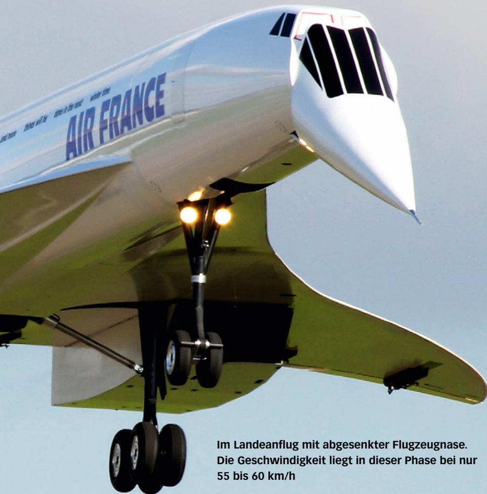
Im Landeanflug mit abgesenkter Flugzeugnase. Die Geschwindigkeit liegt in dieser Phase bei nur 55 bis 60 km/h
