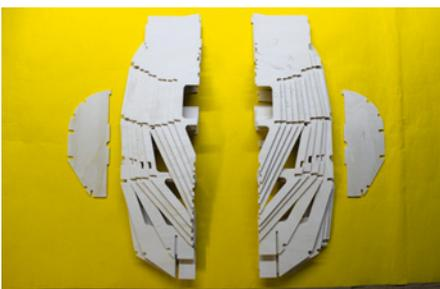
Alle Spanten für den Rumpf einmal gestapelt. Es ist eine linke und eine rechte Hälfte zu bauen
