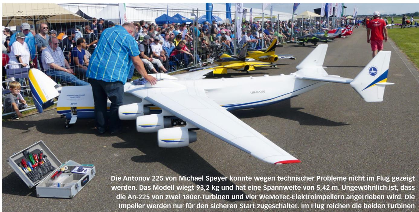
Die Antonov 225 von Michael Speyer konnte wegen technischer Probleme nicht im Flug gezeigt werden. Das Modell wiegt 93,2 kg und hat eine Spannweite von 5,42 m. Ungewöhnlich ist, dass die An-225 von zwei 180er-Turbinen und vier WeMoTec-Elektroimpellern angetrieben wird. Die Impeller werden nur für den sicheren Start zugeschaltet. Im Flug reichen die beiden Turbinen
