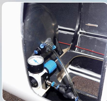
Der Druckluftvorrat für das pneumatische Einziehfahrwerk und die acht Bremsen ist in einem 30 Liter fassenden, geschweißten Alu-Drucktank gespeichert
