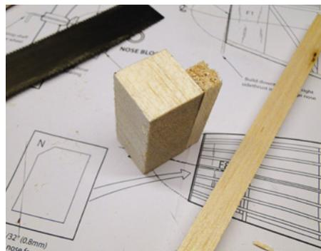
**Kleines Malheur:** Der Klotz für die Rumpfnase ist zu schmal geraten. Aber da liegt ja noch Material zum Auffüttern im Kasten! Leider merke ich zu spät, dass das die Randbögen der Flügel werden sollten
