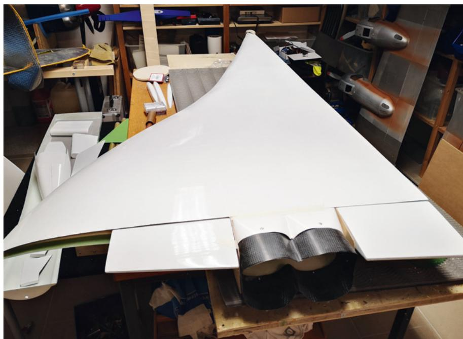
Hier sind die beiden inneren Ruder der Tragfläche bereits angeschlagen. Gut erkennbar ist die Concorde-typische Wölbung der Fläche im Außenbereich – eine echte Herausforderung ist die Anbringung des äußeren Ruders in Hohlkehleintechnik
