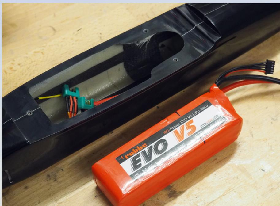
**Im breiten Rumpf ist Platz für größere Akkus, sodass auch etwas längere Motorlaufzeiten möglich sind**
