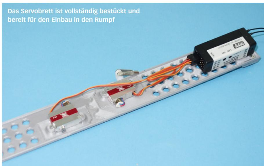
Das Servobrett ist vollständig bestückt und bereit für den Einbau in den Rumpf
