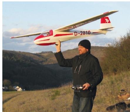
**Abbildung 2: Das 4-m-Modell einer K-8 ist ein schon recht leistungsstarkes Muster aus der frühen Nachkriegszeit – seine vorbildgetreue, geringe Flächenbelastung macht Handstart selbst bei leichtem Wind möglich**
