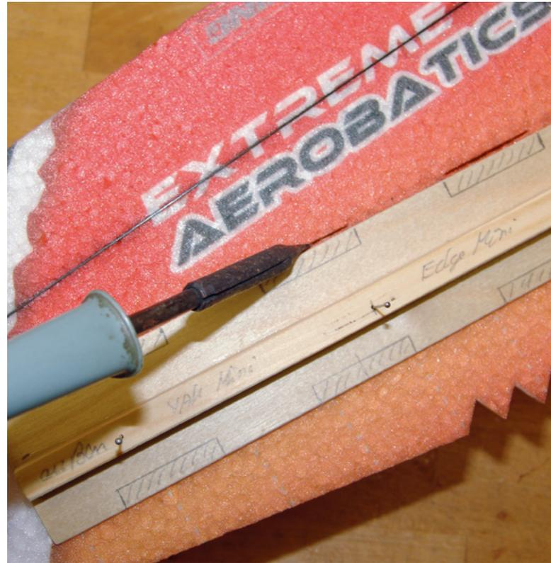
So sind mit der Schmelzlanze exakte Schnitte im EPP-Material möglich
