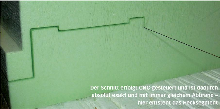
Der Schnitt erfolgt CNC-gesteuert und ist dadurch absolut exakt und mit immer gleichem Abbrand – hier entsteht das Hecksegment
