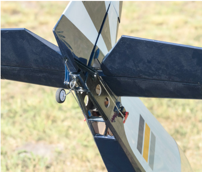
Die Anlenkungen von Höhen- und Seitenrudder arbeiten sehr präzise. Der Luftauslass ist üppig bemessen
