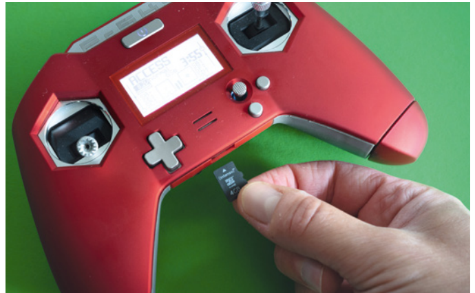
Updates des Senders oder von Empfängern lassen sich mit Hilfe der SD-Karte spielend leicht umsetzen – Update-Dateien stellt FrSky auf seiner Webseite bereit
