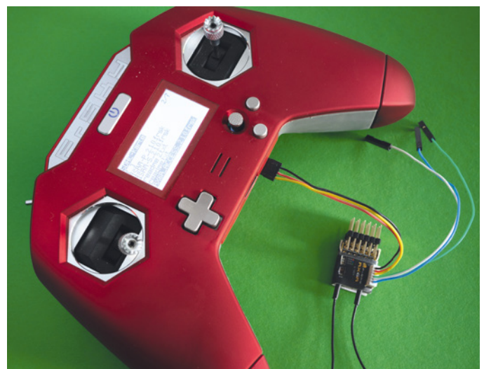
Ältere Empfänger sind noch mit verbundenem Kabel auf den neuesten Softwarestand zu bringen – der RX6R bekommt immerhin ein ACCESS-Upgrade
