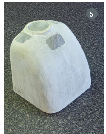
3. Fertige Tragflächenhälfte mit Beplankung und bereit zur Bespannung mit Folie. Zu beachten sind Staurohr, Aufleimer und CFK-Rohr-Verstärkungen. 4. Die selbst tiefgezogene Klarsichthaube sitzt auf einem Träger, der getrennt von der Akkuklappe vom Rumpf abgenommen werden kann. 5. Die Motorhaube entstand zunächst auf einer Positivform und wurde dann ablamiert
