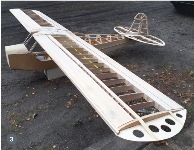
1. Für die neue, massivere Steckung waren Durchbrüche in den Rumpfrippen einzubringen – keine leichte Aufgabe. 2. Probe aufs Exempel: Passt! Die neue Steckung sitzt im rechten Winkel. 3. Einmal zusammenstecken, ob alles richtig sitzt. Sieht auch viel besser als zu Beginn aus. 4. Geschützt durch eine Isoliermatte sitzt der Tank über dem Schalldämpfer in der Kabine
