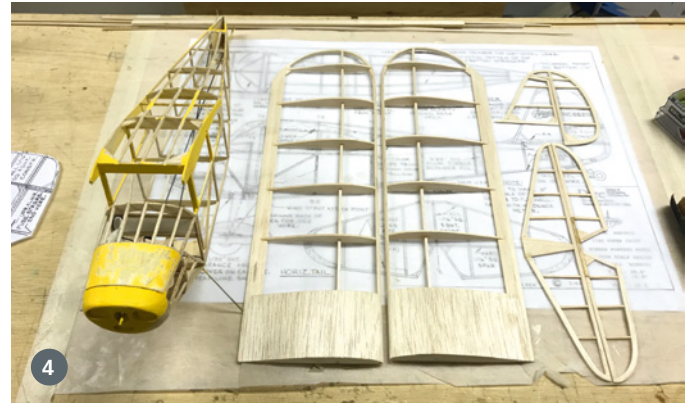
1. Gebaut wird quasi direkt auf dem Bauplan, wobei vor allem Pins helfen. 2. Obwohl es ein sehr filigraner Bau ist, wird das Modell recht stabil sein. 3. Die Optimierung auf Leichtbau beziehungsweise Freiflug ist der Konstruktion anzusehen. 4. Einzelne Modifikationen, beispielsweise die zusätzliche Bepflankung, machen Vieles einfacher
