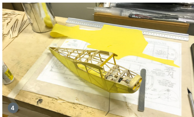
3. Ein Klebestift hilft beim Fixieren des Papiers. Um Bespannlack kommt man aber nicht her. 4. Getriebe-Antrieb und AR6400 sind hier bereits platziert
