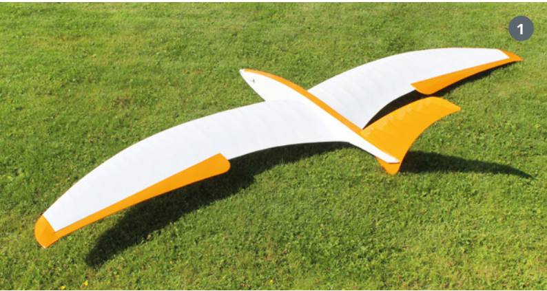
1. Fertiger FlyingCloud mit zweifarbigem Oracover-Finish. 2. Selbstgemachter Motorspant aus 2-mm-GFK, der auf den Holzspant geklebt ist. 3. Blick auf die Querruder mit Balsa-Frästeilen und 2-mm-Balsa-Beplankung
