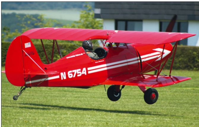
Abbildung 3: Bei diesem Kunstflugdoppeldecker ist das Höhenleitwerk mit klassischen Klappen als Pendelleitwerk lediglich zur Trimmung aufgehängt
