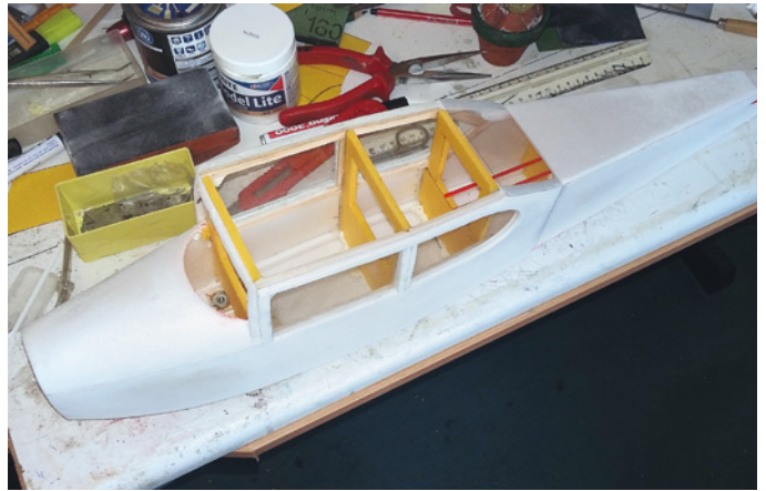
Vielleicht etwas oversized, aber die Verstärkungen des Rumpfs durch 6er-Depron wirken beruhigend
