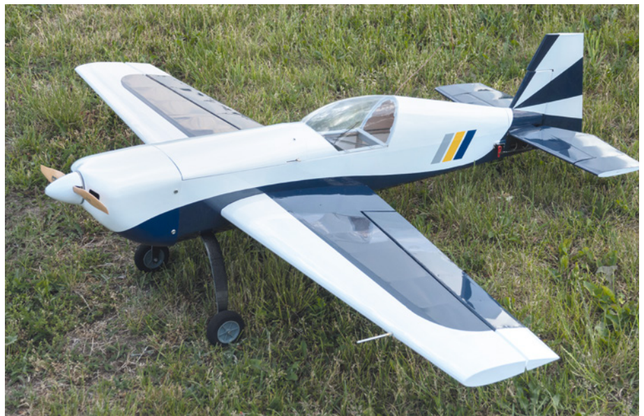
Das Staudruckrohr zur Geschwindigkeitsmessung ragt sichtbar aus der Tragfläche hervor
