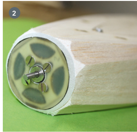
1. Fertiger FlyingCloud mit zweifarbigem Oracover-Finish. 2. Selbstgemachter Motorspant aus 2-mm-GFK, der auf den Holzspant geklebt ist. 3. Blick auf die Querruder mit Balsa-Frästeilen und 2-mm-Balsa-Beplankung
