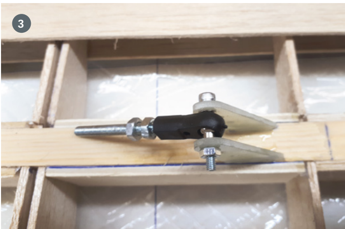
1. Die massiven, geschäfteten Hauptholme einmal aufgereiht. 2. an sich ein normaler Flächenbau, aber erheblich stabiler ausgeführt, als ursprünglich bei diesem Modell begonnen. 3. Stabile M4-Befestigung der Streben an der Fläche sollen künftige Malheurs verhindern. 4. Mit der Oberfräse fräste Reinhard Bluck die Nuten in die Flächenstreben
