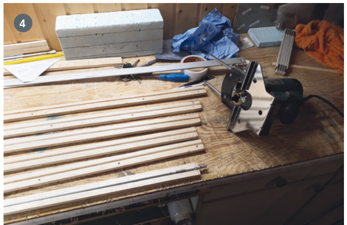
1. Die massiven, geschäfteten Hauptholme einmal aufgereiht. 2. an sich ein normaler Flächenbau, aber erheblich stabiler ausgeführt, als ursprünglich bei diesem Modell begonnen. 3. Stabile M4-Befestigung der Streben an der Fläche sollen künftige Malheurs verhindern. 4. Mit der Oberfräse fräste Reinhard Bluck die Nuten in die Flächenstreben
