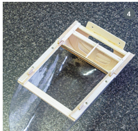
3. Fertige Tragflächenhälfte mit Beplankung und bereit zur Bespannung mit Folie. Zu beachten sind Staurohr, Aufleimer und CFK-Rohr-Verstärkungen. 4. Die selbst tiefgezogene Klarsichthaube sitzt auf einem Träger, der getrennt von der Akkuklappe vom Rumpf abgenommen werden kann. 5. Die Motorhaube entstand zunächst auf einer Positivform und wurde dann ablamiert
