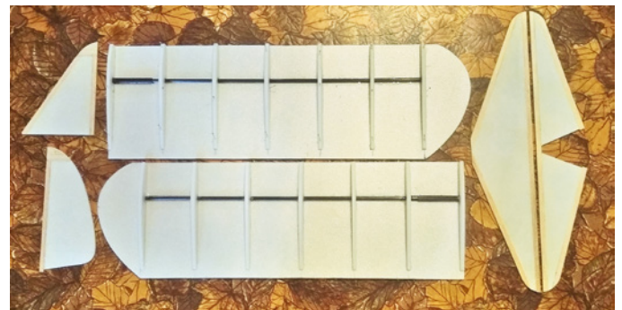
So unähnlich ist die Vorgehensweise zwischen konventionellem und modernem Tragflächenbau nicht: Rippen und Holm sind auch hier identisch
