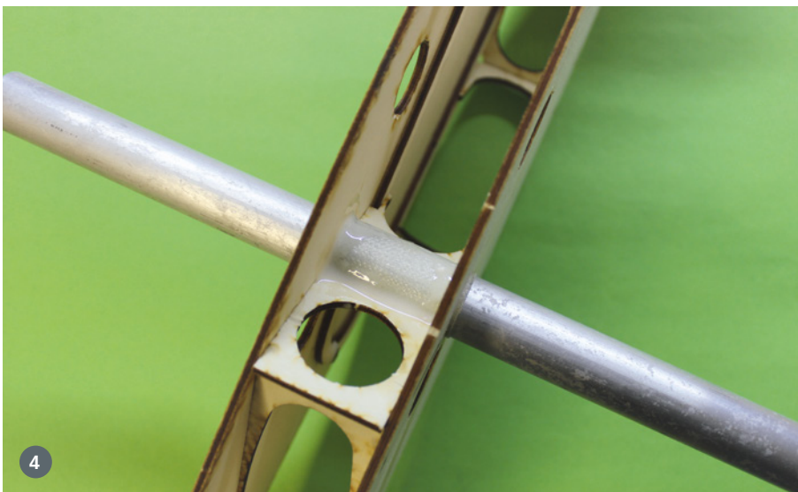
1. In der linken Rumpfseite ist ein großer Deckel eingelassen, damit man gut an den Akku kommt. 2. Dank verschiedener Einsätze für den Flächendübel kann der Winkel zwischen Fläche und Rumpf verstellt werden. 3. So sieht das Rumpferüst innen aus: diagonaler statt üblicher senkrechter Spanten. 4. und 5. Die Flächensteckung besteht aus einem Alu- und einem GFK-Rohr. Im Gegenstück lagert ebenfalls ein passendes GFK-Rohr
