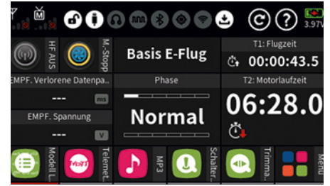
So gibt sich das erste Hauptdisplay mit den Timer-Widgets der fertig angelegten und konfigurierten Timer, welche hier bereits ihre Tätigkeit aufgenommen haben
