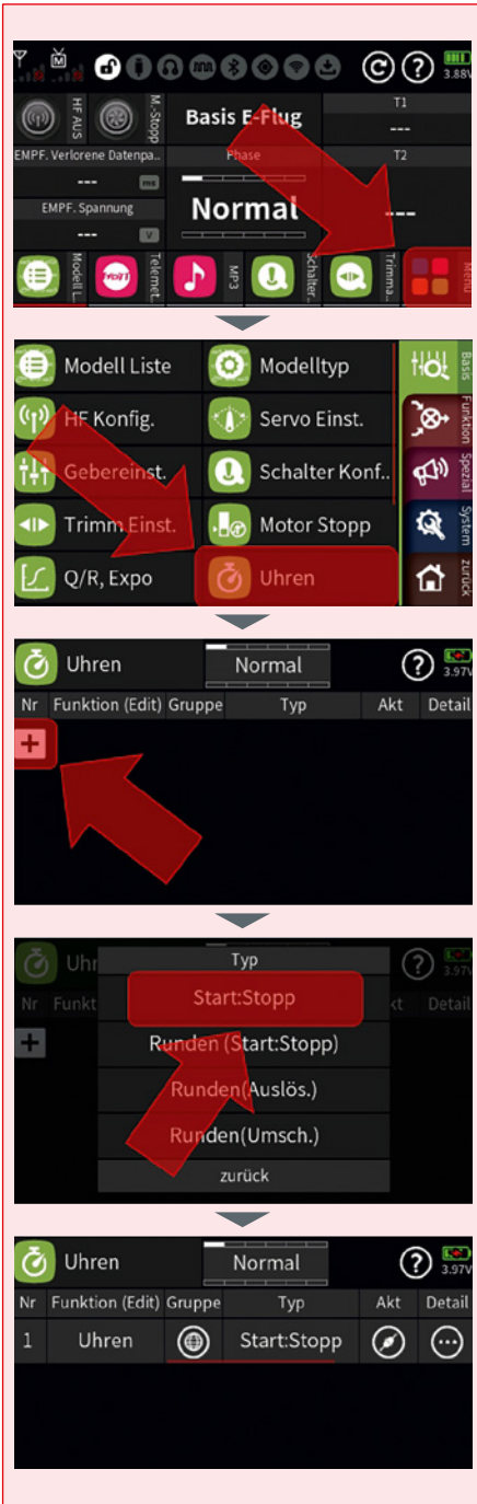
Für die Anzeige der Flugzeit auf dem Hauptdisplay wird zunächst ein neuer Start-Stopp-Timer angelegt, das T1-Widget für dessen Anzeige ist bereits vorbereitet
