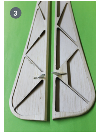
1. Fertiger FlyingCloud mit zweifarbigem Oracover-Finish. 2. Selbstgemachter Motorspant aus 2-mm-GFK, der auf den Holzspant geklebt ist. 3. Blick auf die Querruder mit Balsa-Frästeilen und 2-mm-Balsa-Beplankung
