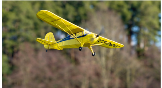
Die Aeronca Superchief wiegt gerade einmal 50 g und wird einzig über einen 1s-LiPo mit Energie versorgt, was zu erstaunlichen 15 Minuten Flugzeit führt. Die Optik der Papierbespannung ist durch nichts zu toppen
