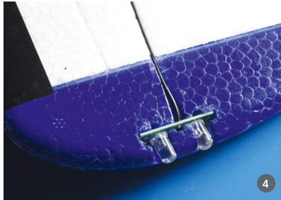
3. Die Streben haben wirklich nur optischen Charakter. Sie werden im Rumpf noch nicht einmal fest verankert. 4. In den Randbögen befinden sich zwei LED für die Positionsbeleuchtung und die Blitzlichter
