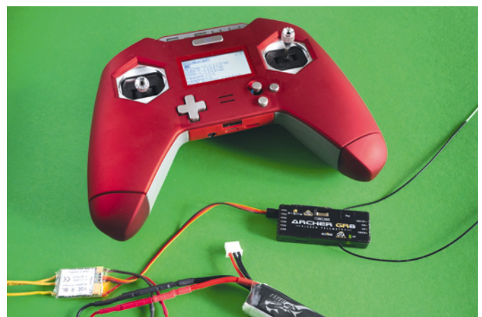
OTA ist neu bei ACCESS und steht für Over The Air. Datenpakete wie Updates werden drahtlos übertragen
