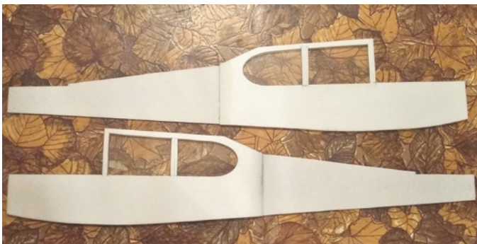
Statt eines Baus in klassischer Balsa-Ausführung entstand diese Auster auf Basis von 3- und 6-mm-Depron
