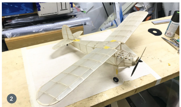
1. Die typische Cowling-Form lässt sich über die Stabbauweise schön realisieren. 2. Manchmal irrt man sich! Diese Bespannung, die lackiert werden sollte, musste wieder runter und machte dem gelben Papier Platz
