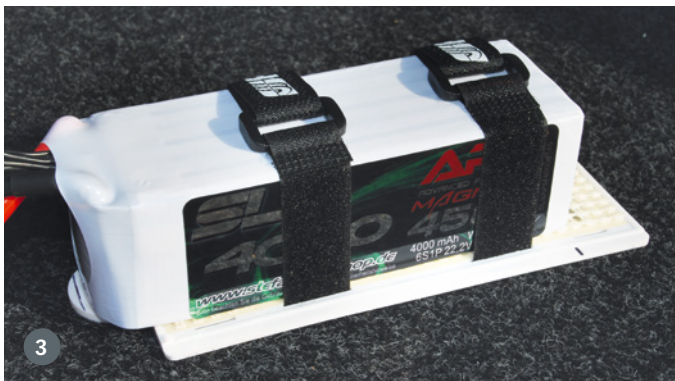
1. Alle Servos kommen eingebaut, mit verlegten Kabeln und spielfrei angeschlossenen Gestängen zum Kunden. 2. Perfekte Passung auch beim Übergang des Spinners zum Rumpf. Unter der Haube werkelt ein kraftvoller 460-kv-Brushlessmotor an 6s-LiPos. 3. Die Akkuwippe ermöglicht eine komfortable und sichere Platzierung des LiPos im Rumpf. Ein Stück mit doppelseitigem Klebeband aufgebrachte Teppich-Rutschsicherung hilft auch an dieser Stelle. 4. Die Querruderservos sitzen in der unteren Tragfläche. Stangen nehmen die oberen Klappen mit
