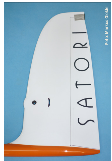
Abbildung 12: Beispielhaft für einen Thermiksegler mit Pendelleitwerk ist der Satori von aer-o-tec. Hier gut zu sehen ist die Leitwerkslagerung und -anlenkung
