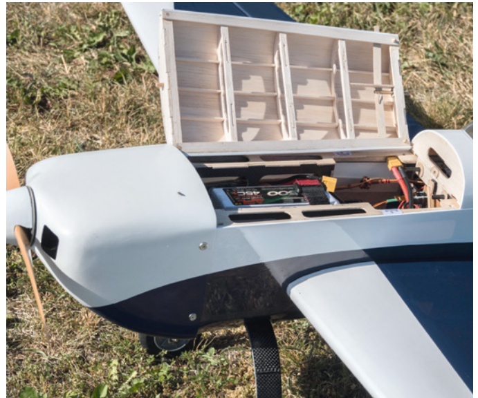
Die großzügige Klappe hinter der Motorhaube erlaubt einen bequemen Zugriff auf den 5s-LiPo.
