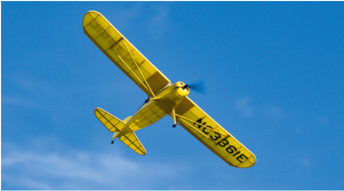
Die Aeronca Superchief wiegt gerade einmal 50 g und wird einzig über einen 1s-LiPo mit Energie versorgt, was zu erstaunlichen 15 Minuten Flugzeit führt. Die Optik der Papierbespannung ist durch nichts zu toppen
