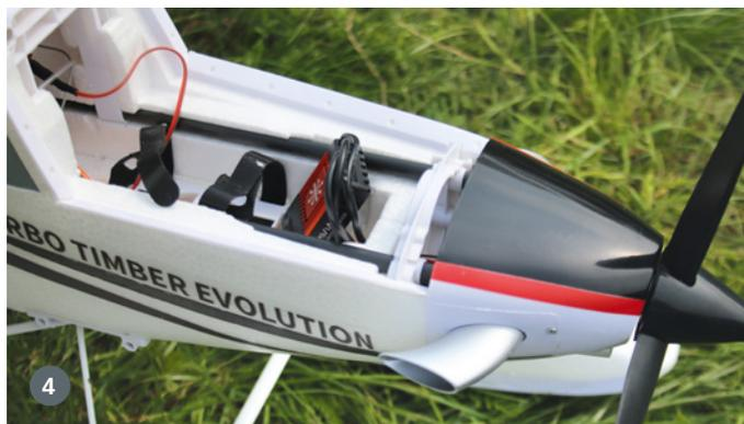
1) Die zwei Hartschaum-Schwimmer werden mit Stahlprofilen verbunden. 2) Kunststoffblöcke bilden die Knotenpunkte für die Strebenkonstruktion. 3) Wasserabweiser an den Innenseiten der Schwimmer verhindern Spritzwasserfontänen. 4) Der Avian-Smart-Regler ermöglicht im Zusammenspiel mit dem passenden Spektrum-Sender die Gegenschub-Funktion
