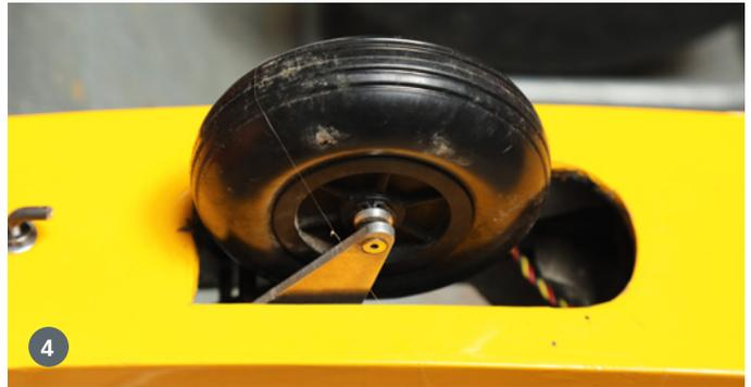
1) Den Knick hat der Autor mit einer Alu-Lasche verstärkt. 2) Verkastung und Beplankung nehmen ihren Fortgang. 3) Man sieht deutlich das Problem: der Steuerdraht biegt sich unter Druck um, das Höhenruder kann im Flugbetrieb nicht nach oben bewegt werden. 4) Bei der Impellerversion wird ein Einziehfahrwerk montiert
