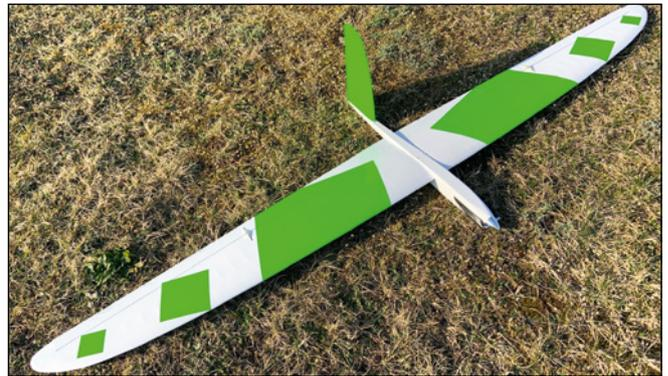
**Bild 7:** Der Amokkamoldt besitzt ein sehr großes Seitenleitwerk auf Grund der geringen Rumpflänge
