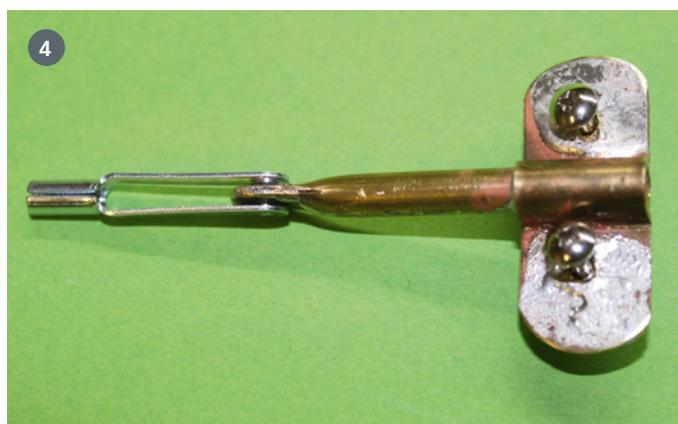
1) Über das Pitot-Rohr ist der Haubenverschluss realisiert – hinten halten Magnete die Kabine. 2) Bei der Seitenrudergröße fällt die Dämpfungsflosse extrem klein aus. 3) Blick auf die Scharniere am Seitenleitwerk. 4) Das Ruderhorn für das Höhenruder
