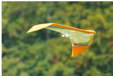
**Nasenleiste und Winglets des FunWing sind aus EPP, der Flächenkern ist aus Elapor**
