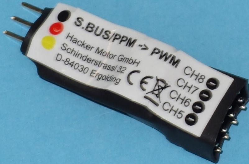
Der S.BUS => PPM-Converter von Hacker wird an einen S.BUS-Ausgang des Empfängers angeschlossen und dekodiert das S.BUS-Signal in vier einzelne PPM-Signale. So wird am Empfänger nur ein Ausgang belegt und es lassen sich trotzdem vier Servos ganz individuell ansteuern. Der Converter ist erhältlich für die Kanäle 1 bis 4 oder 5 bis 8, wiegt nur 5 g und ist mit seinen Maßen von 11 x 36 x 10,5 mm sehr klein. Die Belastbarkeit von vier mal 1,5 A reicht für viele Funktionen aus.
