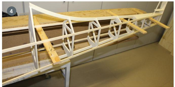
1) Kleine Sperrholzdreiecke verleihen dem Höhenleitwerks-Gerüst noch mehr Stabilität. 2) Befestigung des Höhenleitwerks und Anlenkung des Höhenruders mit CFK-Rohr. 3) Der Flächenaufgabebereich ist massiv ausgeführt und soll später die Flügel sicher aufnehmen. 4) Blick auf den hinteren Rumpfbereich mit seinen Stringern und Spanten
