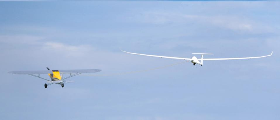
Auf die Distanz sieht alles kleiner aus, aber im Schlepp der 4.260 mm spannenden Carbon Cub SS von Grupp ist eine 7.500 mm spannende Diana-2 von Chocofly
