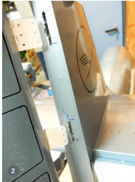
1) Das Spornrad ist an einem stabilen Sperrholzspant befestigt. 2) Am Seitenleitwerk müssen noch die Schlitz für die Kunststoffscharniere gefräst werden
