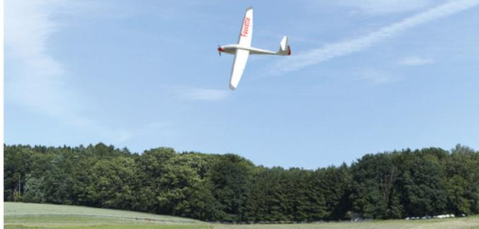
Zu den im Simulator umgesetzten Downloadbauplan-Modellen zählt auch Fauvette, ein 2.600 mm spannender Elektrosegler in Holzbauweise, natürlich inklusive Störklappenfunktion
