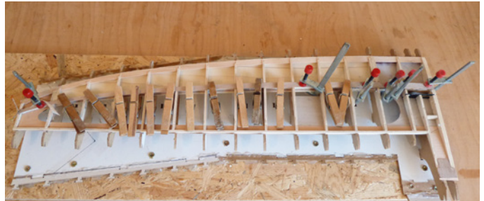
Der untere Holmgurt wird eingeklebt
