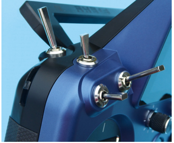
Für die Bedienung stehen beidseitig jeweils vier Schalter und ein Schieberegler bereit
