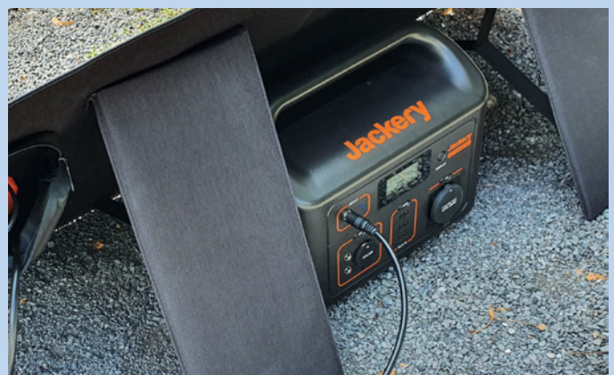
In der prallen Sonne wird's auch mal unangenehm heiß, sodass sich der Generator lieber im Schatten aufhalten sollte, sonst bekommt er einen Sonnenstich
