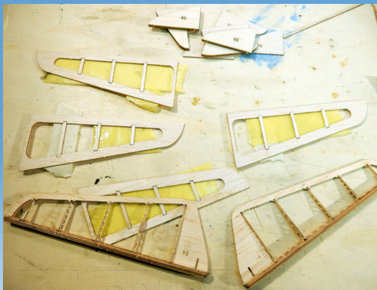
Fixiert durch Klebestreifen werden die Rippenaufleimer mit der Beplankung verklebt. Viermal darf man diese Arbeit für die beiden Höhenrunderklappen machen ...
