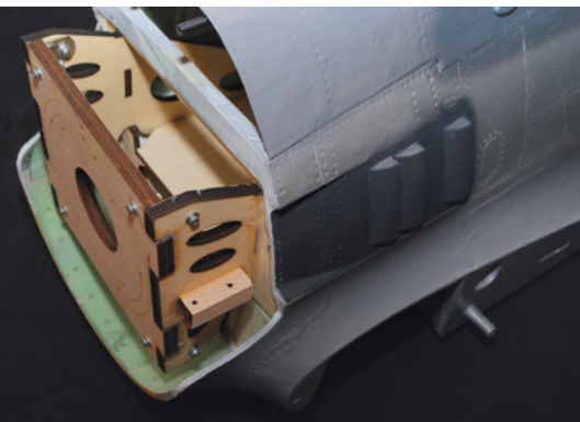
Am Brandschott lassen sich gut verschiedene Antriebe montieren. Ideal ist das auch für den Einbau eines Mehrzylinder-Motors
