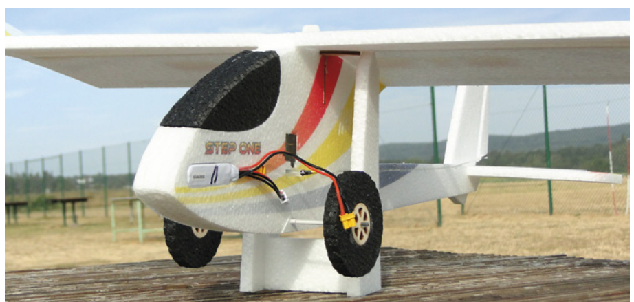
Die Schwerpunktwaage aus EPP wird mitgeliefert – eine pffiffige Idee!
