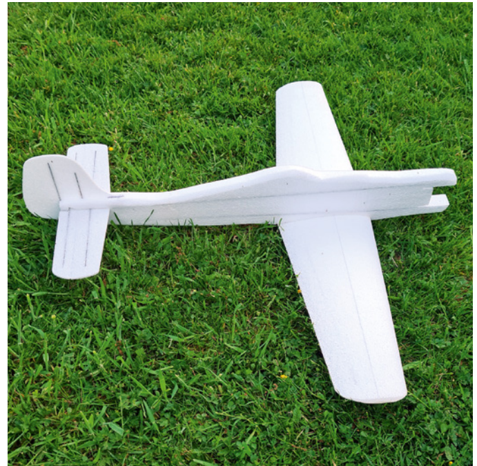
Alle Teile entstehen aus verschiedenen dicht geschäumten EPP-Platten und sind mit CFK-Profilen zu versteifen
