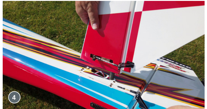
3) Die Tragflächen werden über je zwei CFK-Schiebeelemente verriegelt. So benötigt man zum Aufbau des Modells kein Werkzeug. Beim Aufsetzen der Kabinenhaube blockiert diese ein mögliches selbstständiges Entriegeln. Nach Montage der Kabinenhaube wird diese mittels magnetischer Bolzen verriegelt. 4) Wie bei den Flächen werden auch die beiden Höhenruderhälften mit je zwei Schiebern verriegelt und durch magnetische Bolzen gesichert.
