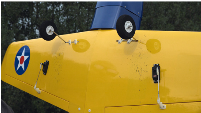
Neben der Motorhaubenmontage sind beim PNP-Modell beispielsweise auch die Fahrwerke zu verschrauben
