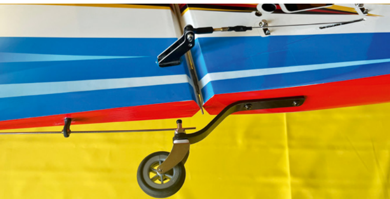
Das Heckfahrwerk besitzt einen CFK-Bügel, der mit zwei M3-Schrauben befestigt wird. Angelenkt ist das Ganze über einen Kugelkopf, der den Lenkdraht mit dem Seitenruder verbindet
