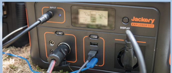
Die Anschlüsse der Generator-Box: Oben links geht's zum Solarpanel und unten reihen sich die drei separat zuschaltbaren Spannungsversorgungen auf für 12 V (10 A), USB (3 x je 2,4 A) und eine 230-V-Netzsteckdose
