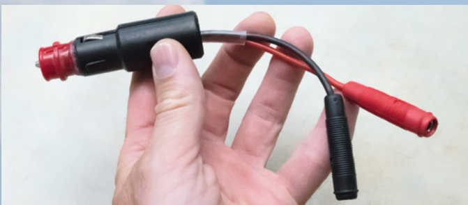
An der 12-V-Versorgungsseite steht im Wesentlichen der vom Camping bekannte Zigarettenanschluss mit 10 A Maximalstrom zur Verfügung. Hierfür wurde ein Adapter mit 4-mm-Buchsen konfektioniert
