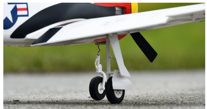
Die vorbildähnlichen Einziehfahrwerke sind mechanisch robust ausgeführt
