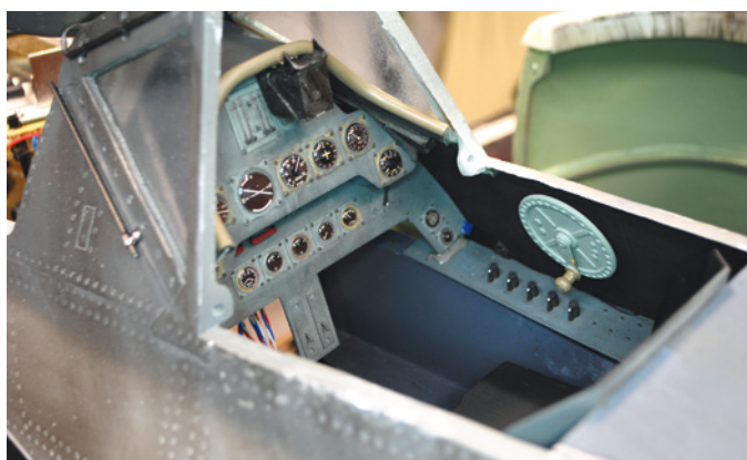
Über das kleine Handrad wird das Fahrwerk bedient – es fand sich noch in einer Restekiste. Optional ist der Cockpitausbau, der ebenfalls etwas modifiziert wurde
