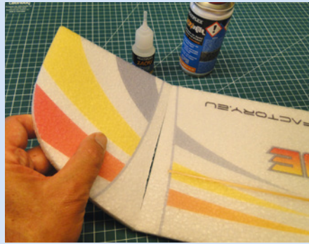
Die Flügelohren werden einfach mit CA-Kleber an das Mittelstück geheftet
