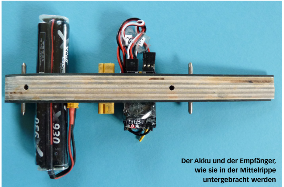
Der XT 30 Stecker für den Empfängerakku schaut minimal aus der Mittelrippe heraus und schließt später mit der CFK-Rippe ab
