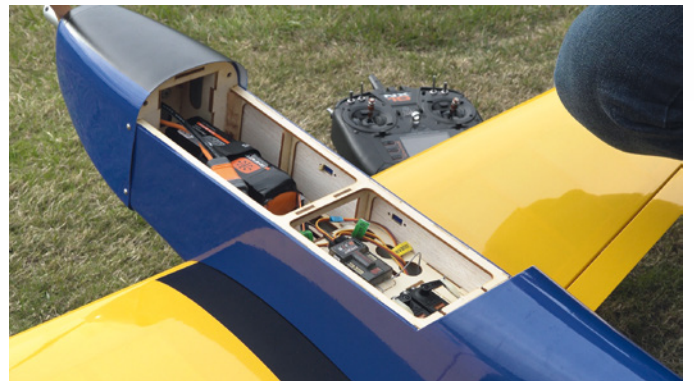
Es eignen sich 4s- bis 6s-LiPos. Die Servos und der Regler sind ab Werk montiert, der Empfänger ist extra zu ordern
