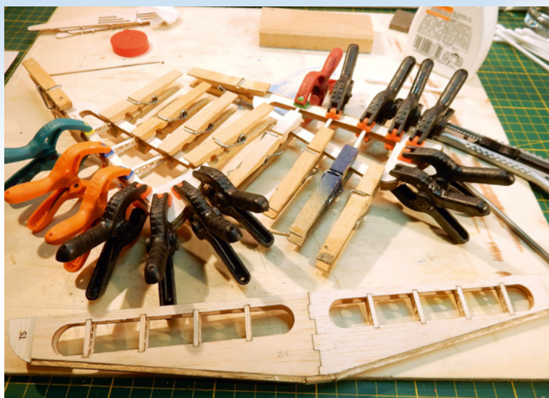
... dann kann die Beplankung symmetrisch auf die Rippen geklebt werden
