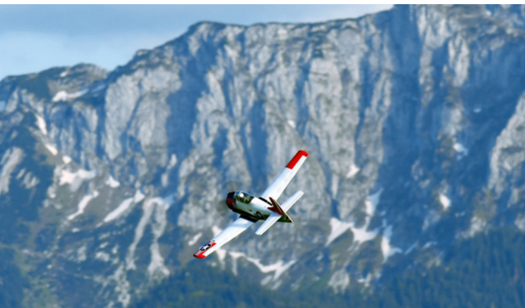
An die zehn Minuten Flugzeit hat man mit einem 4s-LiPo-Akku mit einer Kapazität von 2.400 mAh
