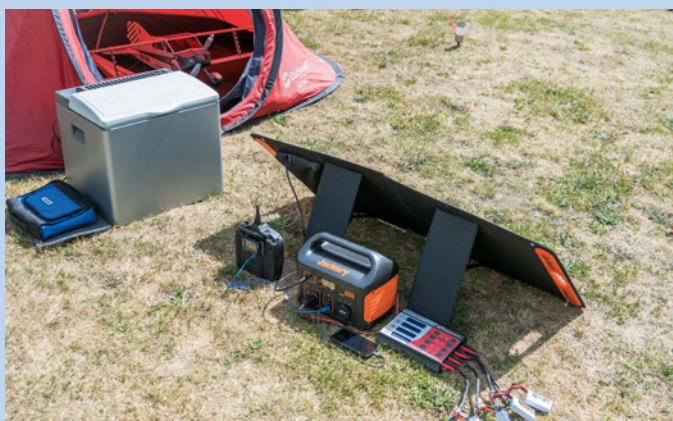
Das war eigentlich die Wunsch-Konstellation, aber alles solar laden und auch noch die Kühlbox zu betreiben, ging nicht – die Kühlbox verbrauchte zu viel Strom
