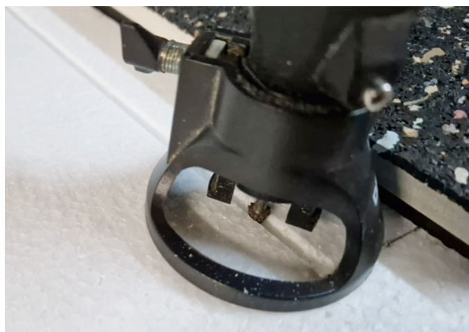
Fräsen der Querruderscharniere mit einem Dremel und geführt über einen Anschlag
