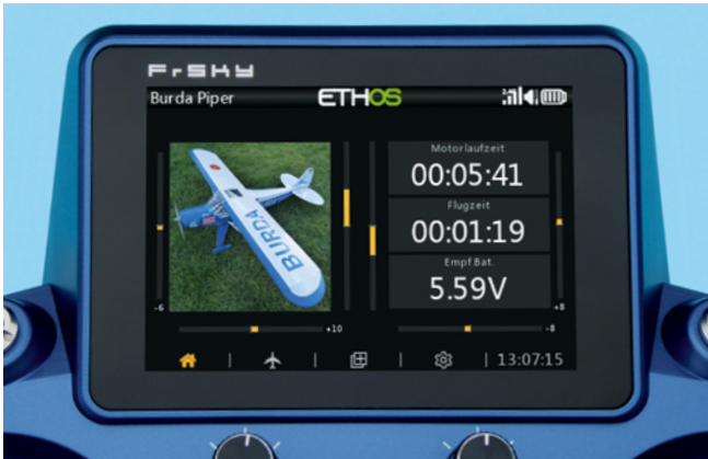
Der große farbige Touchscreen liegt optimal im Blickfeld des Piloten
