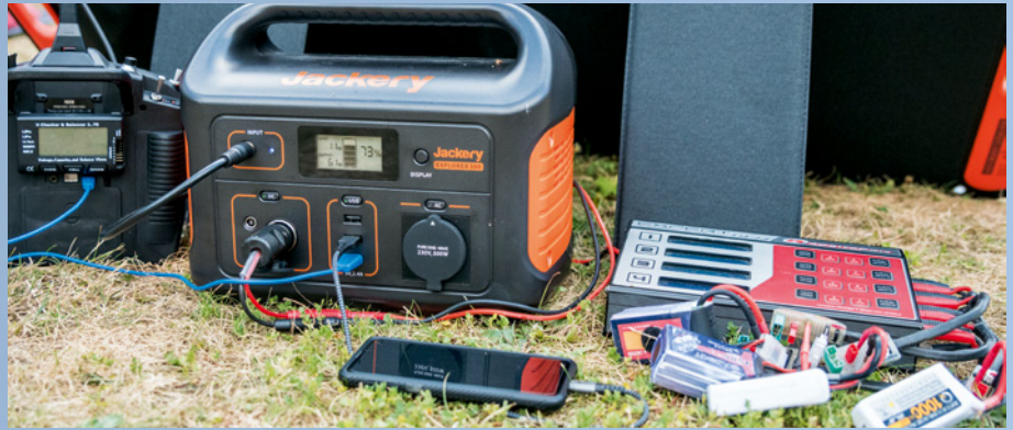
Bei diesem Bild zog eine hinterhältige Wolke vorbei, sodass die Solarzelle von den benötigten 61 W nur müde 11 W zurückspies. Aber keine Panik: Der integrierte 500-Wh-Puffer hatte noch satte 73% übrig
