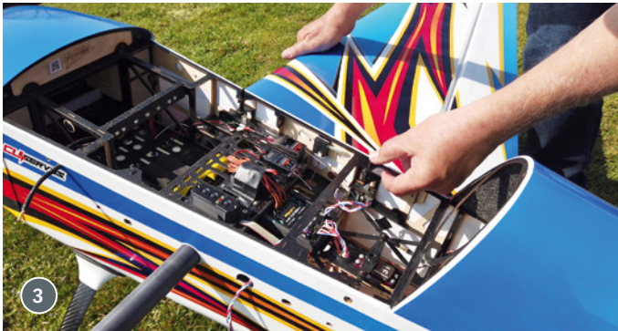
3) Die Tragflächen werden über je zwei CFK-Schiebeelemente verriegelt. So benötigt man zum Aufbau des Modells kein Werkzeug. Beim Aufsetzen der Kabinenhaube blockiert diese ein mögliches selbstständiges Entriegeln. Nach Montage der Kabinenhaube wird diese mittels magnetischer Bolzen verriegelt. 4) Wie bei den Flächen werden auch die beiden Höhenruderhälften mit je zwei Schiebern verriegelt und durch magnetische Bolzen gesichert.
