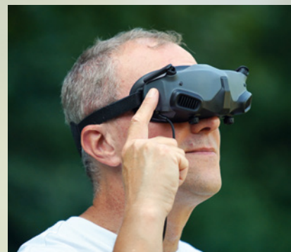
Die Navigation durch im Display eingeblendete Menüs erfolgt über ein Touchfeld per Fingergesten
