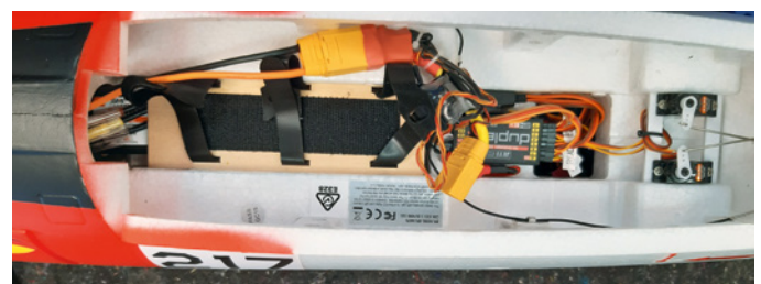
Ab Werk sind bereits Servos und Regler installiert – jedoch wurde das Stecksystem nachträglich geändert. Das Akkubrett lässt Spielraum zum Platzieren des Akkus
