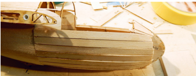
Der Bugbereich wird mit einzelnen Leisten beplankt und die Nase mit Balsfüllstücken aufgefüttert ...
