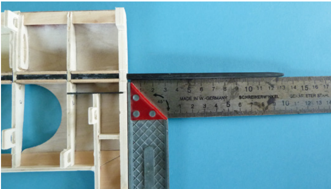
An der Wurzelrippe wird der rechte Winkel zum Flächenverbinder kontrolliert
