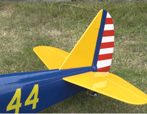
Die Leitwerke werden gesteckt und verschraubt, die Ruderanlenkungen sind aber noch teils zu erstellen
