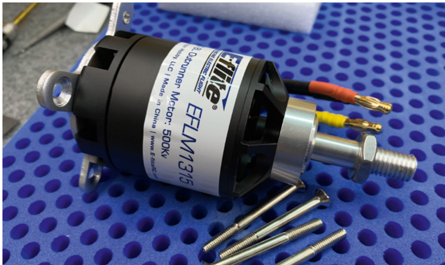
Der Brushless-Motor liegt gesondert bei und wird über Distanzbolzen befestigt
