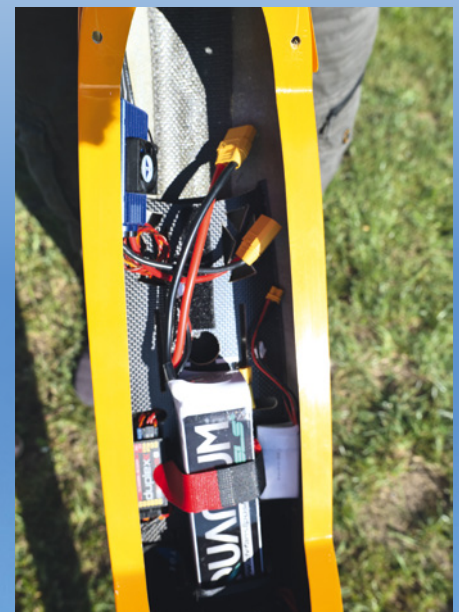
Logisch, dass es im Inneren des CFK-Rumpfs ziemlich dunkel ist. Der Akku passt optimal zur Schwerpunkteinstellung
