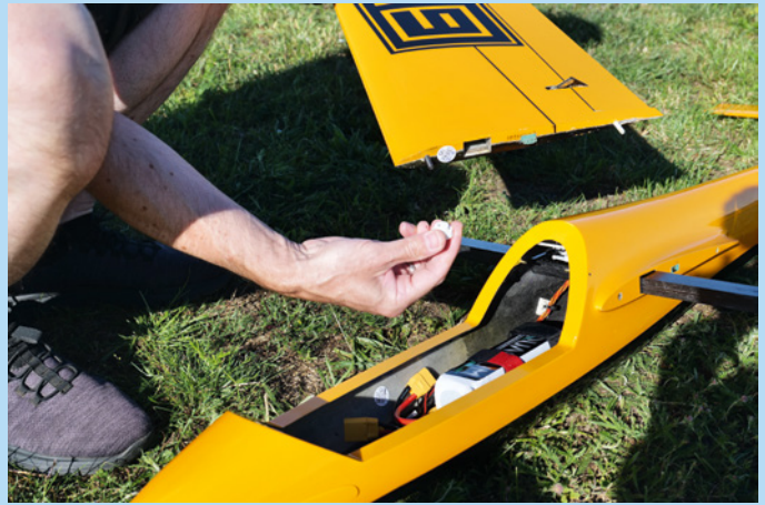
Über Rändelschrauben wird die Fläche im Rumpffinneren gesichert
