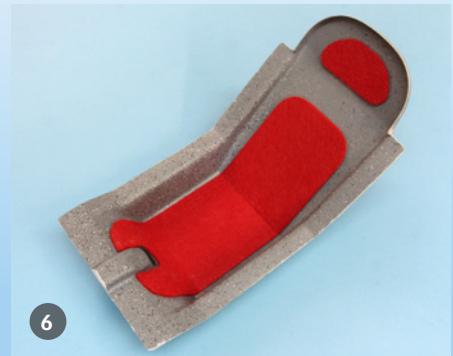
4) Ein selbst erstellter GFK-Motorspant hält den Motor in Position. Neben den Befestigungsbohrungen gibt es zusätzliche Löcher zur Kühlung des Antriebs. 5) Die Kabinenhaube muss sorgfältig an den Haubenrahmen angepasst werden. Hier hilft nur Geduld und eine fortwährende Überprüfung der Passung zwischen den Bearbeitungsschritten. 6) Roter Filz als Polster-Ersatz sorgt für etwas Farbe im Cockpit
