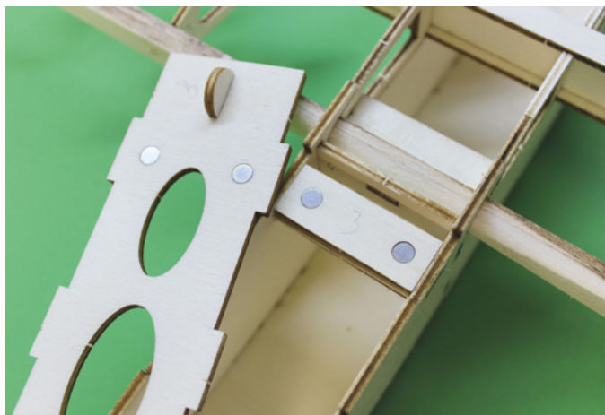
Rumpfdockel mit Magneten und die Zapfenkonstruktion sorgen für einen sicheren Einbau
