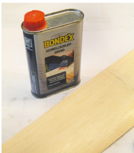
Mit Schnellschleifgrund erzeugt man eine glatte Oberfläche für die folgende Lackierung
