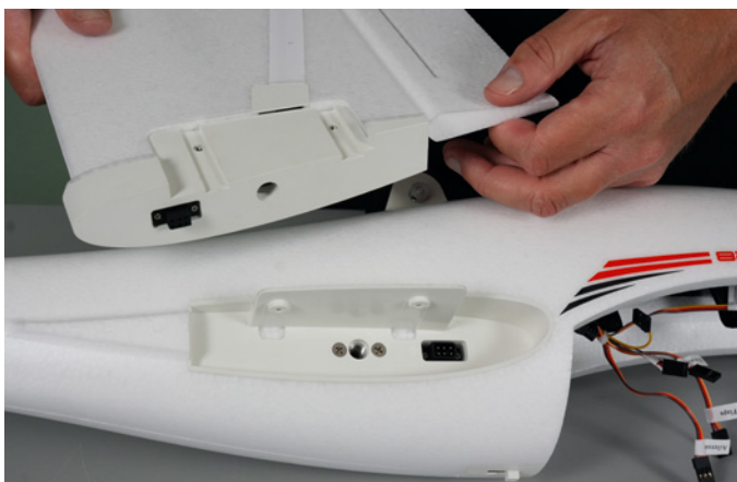
Mit dem Aufstecken der Flügel steht auch die Stromverbindung zu den Servos. Metallschrauben sichern nach dem Aufstecken die Laschenverbindung der Flächen
