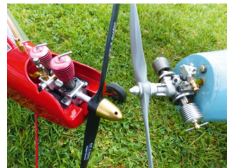
Der Star der Veranstaltung war eindeutig dieser Zweizylinder-Reihen-Dieselmotor mit 1,6 cm 3 , der im Selbstbau von Luitpold Fiess aus Sonthofen gefertigt wurde. Der 1,6-cm 3 -Diesel-Boxermotor kommt dagegen aus England und wird von Alex Phin vertrieben
