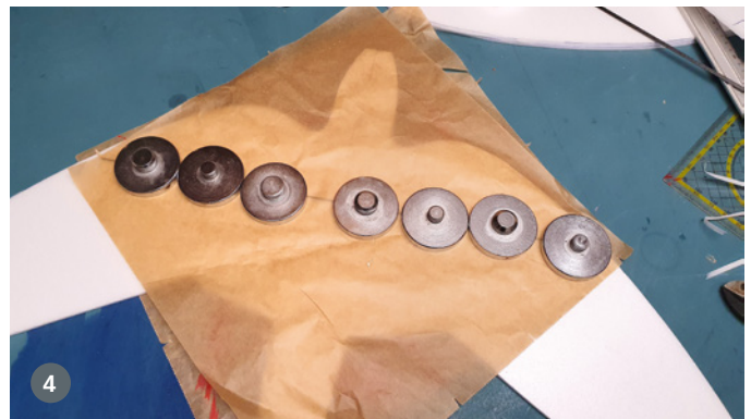
4 Backpapier sorgt dafür, dass nur die gewünschten Teile miteinander verkleben. Die Gewichte halten alles plan, bis der Klebstoff getrocknet ist
