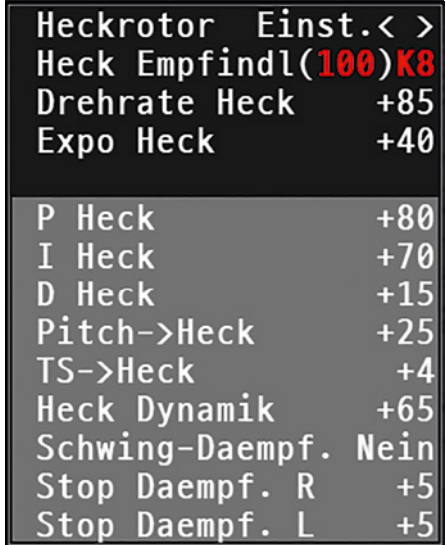
Das Menü für den Heckrotor. Auch hier gehören die grau hinterlegten Zeilen zum Expertenmodus. Das Gain wird über Kanal 8 gesteuert und steht hier auf 100%
