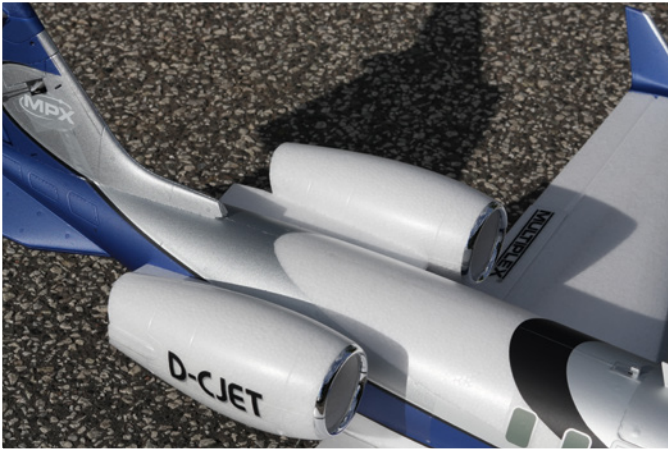
In den Gondeln sind Zweiblatt-Impeller mit 50 mm Durchmesser und 4.600-kv-Brushless-Motoren montiert
