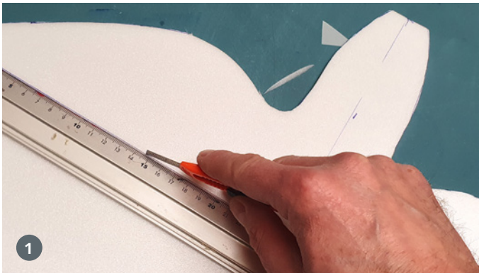
1 Für den CFK-Holm wird ein 1 mm breiter Schlitz geschnitten. Zum Schneiden ist generell eine frische Klinge zu benutzen
