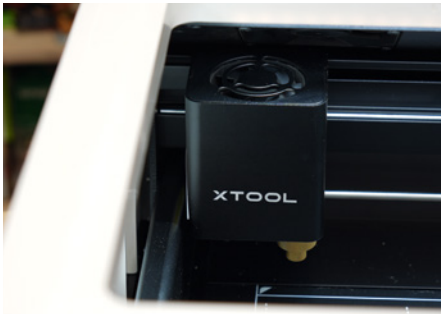
10 W Leistung bringt der Laser im xTool M1 und damit genug Power zum Schneiden verschiedener Hölzer bis 8 mm Materialstärke
