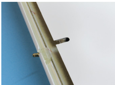
Links: Da die Tragfläche ohne Durchbrüche für die Gestänge geliefert wird, ist zuerst der Servorahmen einzukleben, dann die Position der Gestänge zu markieren und abschließend sind die Durchbrüche zu fräsen. Rechts: Die Ausschrauben werden satt mit eingedicktem Harz in die Ruder eingeklebt
