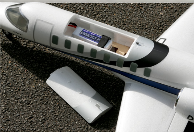
Zum Betrieb sind 4s-LiPos erforderlich. Der Schwerpunkt lässt sich durch Verschieben des Akkus einstellen
