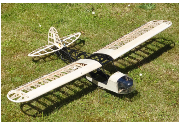
Trotz nur 1.000 mm Spannweite erfordert der Savage Bobber den identischen Bauaufwand wie ein wesentlich größeres Modell – das Ergebnis kann sich dafür sehen lassen
