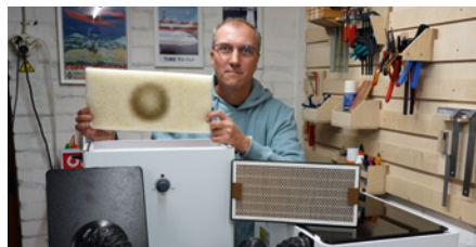
Der mehrschichtig aufgebaute Abluftfilter saugt effektiv Branddämpfe ab und sorgt für ein angenehmes Arbeitsklima
