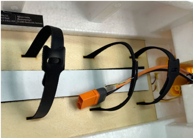
Klettschlaufen und -band sichern den Flugakku auf dem Akkubrett. Das EC5-Stecksystem übermittle praktischerweise Telemetriedaten des Akkus
