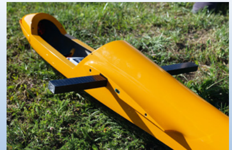
Die massive CFK-Vierkant-Flächensteckung sitzt perfekt und hat ein moderates Gewicht
