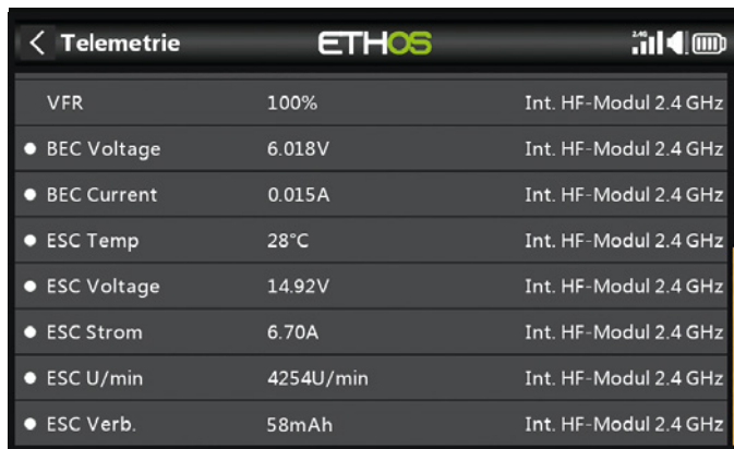
Ein Neuron-II-Regler stellt umfangreiche Telemetriedaten zur Verfügung
