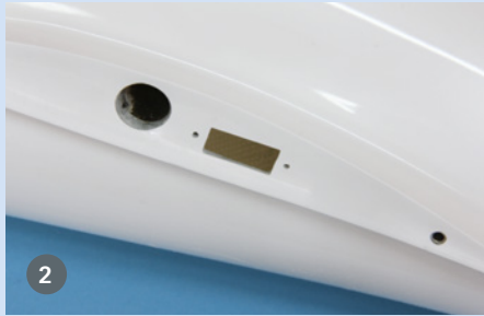
1) Der selbst gelötete Kabelbaum ist bereit zum Einbau. Die Schaumgummistücke verhindern ein Klappern der Kabel im hohlen Flügel. 2) Rumpfsseitig wird der Stecker mit einem Rahmen an die Wurzelrippe geschraubt. 3) Flächenseitig bleibt das Kabel lose. Diese Form der Steckverbindung ist sicher und hat sich vielfach bewährt
