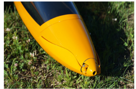
Farblich passend lackierter Propeller und Spinner. Mit 16 x 10 Zoll ist der Prop optimal gewählt
