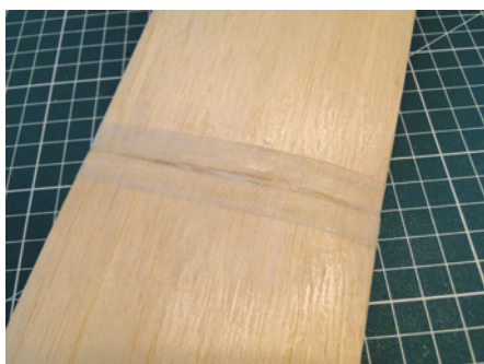
GFK-Band und Epoxidharz halten die beiden Flügelhälften zusammen
