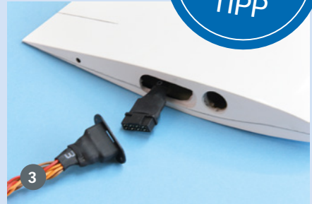
1) Der selbst gelötete Kabelbaum ist bereit zum Einbau. Die Schaumgummistücke verhindern ein Klappern der Kabel im hohlen Flügel. 2) Rumpfsseitig wird der Stecker mit einem Rahmen an die Wurzelrippe geschraubt. 3) Flächenseitig bleibt das Kabel lose. Diese Form der Steckverbindung ist sicher und hat sich vielfach bewährt
