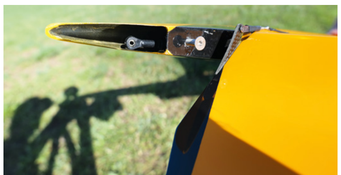
Die Höhenruderanlenkung erfolgt über ein lösbares Kugelgelenk und ist gut zugänglich
