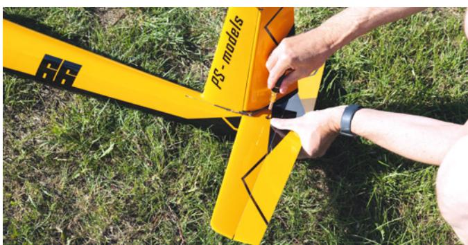
Das Höhenruder lässt sich ganz leicht demontieren beziehungsweise über Schrauben befestigen
