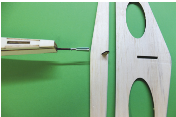
Praktischerweis kann die CFK-Schubstange zur Anlenkung des Höhenruders direkt aus dem Rumpfbrett austreten
