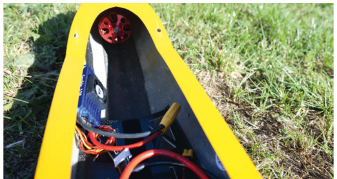
Blick ins Rumpfinnere und auf den Leopard-Motor, der leistungsmäßig ideal passt
