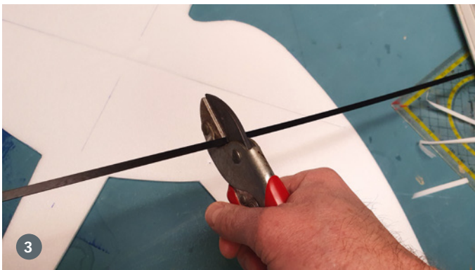
3 Mit einer Amboss-Gartenschere lassen sich CFK-Profile sehr gut ablängen
