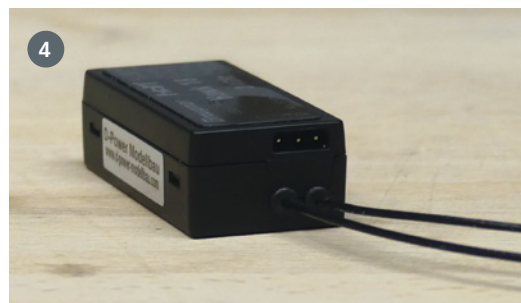
3) Auf der vorderen Stirnseite befinden sich 6 + 2 Buchsen für den Anschluss von bis zu acht Servos. 4) Auf der Rückseite liegen die Buchse für Sensoren oder das neunte Servo sowie die 145 mm langen Antennen
