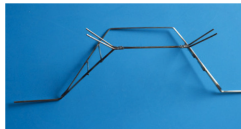
Das Fahrwerk liegt als fertig gelötetes Bauteil bei. Diese Arbeit hat einem der Hersteller damit abgenommen
