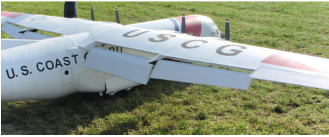
Weit herausragende Fowlerklappen sind seit 2007 in der Tragfläche integriert. Sie helfen wirksam beim Landen
