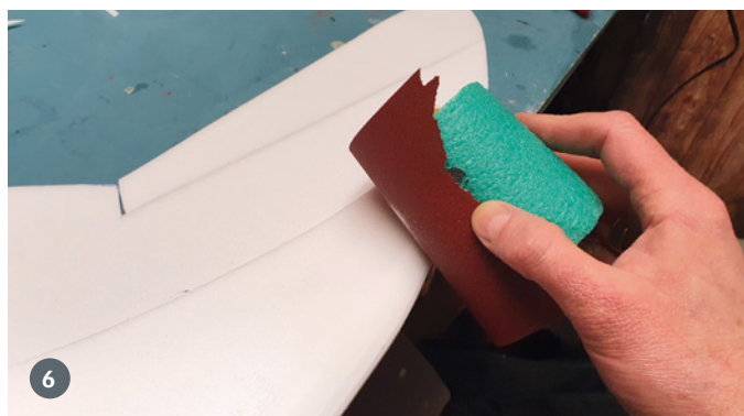
Ein Stück Schwimmmulde als Schleifklotz ist ideal für das Schleifen der Nasenleisten
