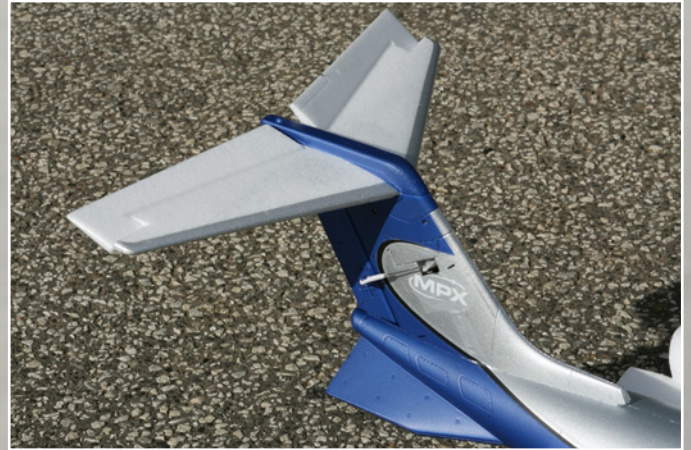
Jedes Höhenruder wird über ein eigenes Servo angesteuert. Insgesamt sind acht Servos im Modell verbaut
