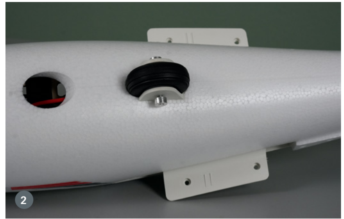
1) Alle Lenkgestänge sind ab Werk betriebsbereit und mit passenden Längen montiert. Dünne Alu-Stangen garantieren die Mitnahme der Klappen auf ganzer Länge. 2) Zum Ausrollen nach dem Landen eignet sich das starre Landerad sehr gut
