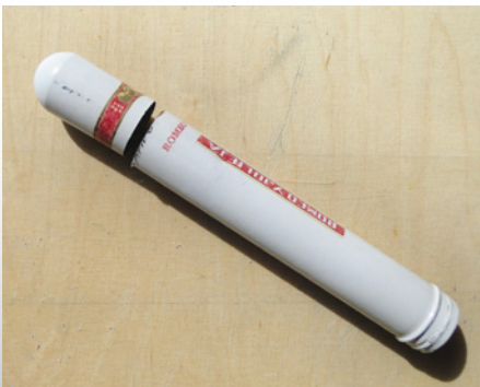
Das Ende der Zigarrenhülse ist die perfekte aerodynamische Verkleidung für den neuen Raketenmotor
