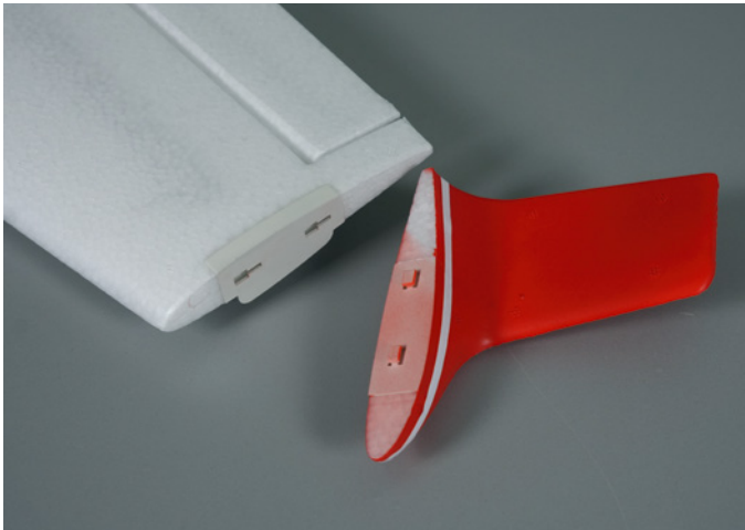
Wie praktisch, dass die Winglets einfach angesteckt werden und es pro Seite jeweils einen Ersatz gibt
