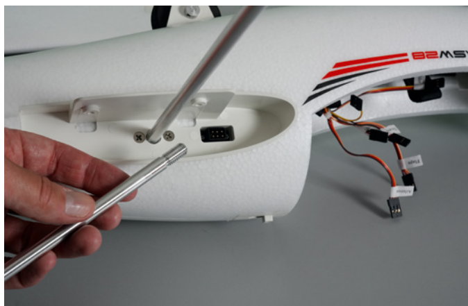
Mit Gewinde versehene, massive Alu-Stangen dienen als Flächenverbinder und sind noch im Metallgewinde des Kunststoffteils einzudrehen
