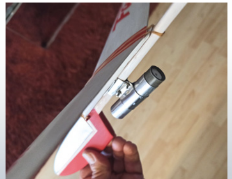
So ist das Triebwerk unter dem Rumpf montiert, hier noch ohne „Zigarren-Verkleidung“
