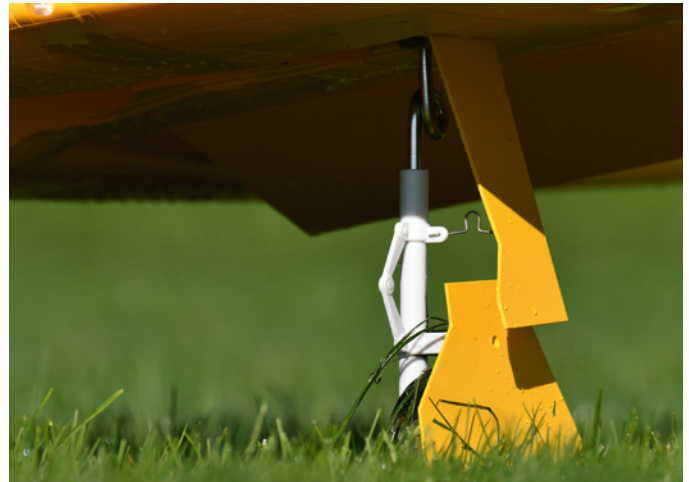
Eine Drahtfeder zieht den Fahrwerksdeckel an die authentisch aussehende Kulisse des elektrischen Fahrwerks
