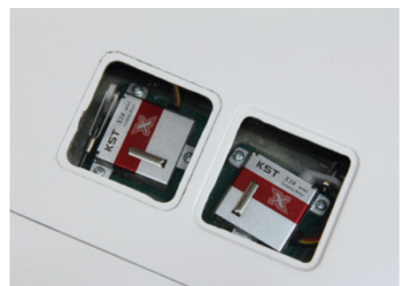
An der schrägen Einbauposition des Störklappenservos darf man sich nicht stören. Wichtiger ist es, dass die Anlenkung geradlinig zur Störklappe hin verläuft
