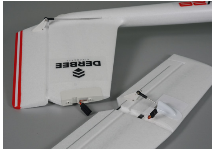
Erst die Kabelverbindung herstellen, dann das Höhenleitwerk mit zwei Metallschrauben sichern – fertig
