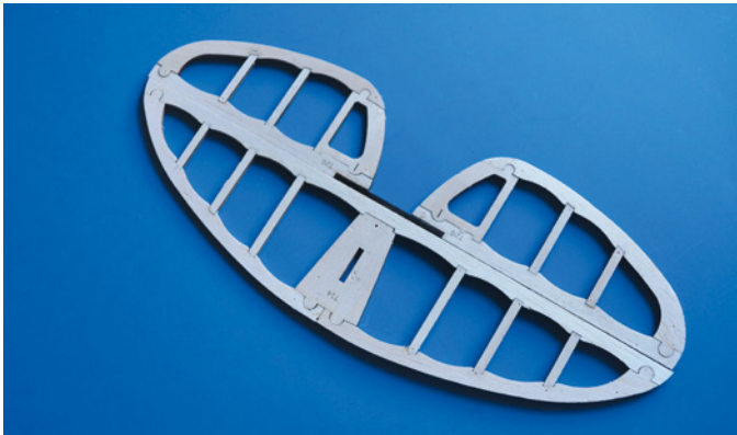
Das fertig verschliffene Höhenleitwerk
