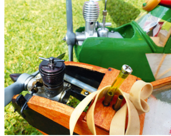
Der Taifun Hobby war in den 1960er- und bis in die frühen 1970er-Jahre der wohl weitverbreitetste Modelldiesel in Deutschland und bis 1975 im Graupner-Sortiment. Mit seinen 0,98 cm 3 Hubraum ist er ein idealer Antrieb für Modelle mit etwa 500 g Abfluggewicht
