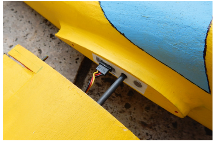
Steckung, Positionierstifte, Servoanschluss und Magnet zur Arretierung der Flügel
