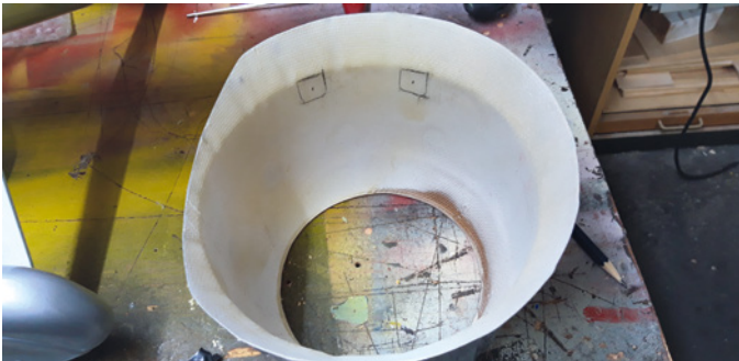
Die Position der Abstandshalter sollte durch die nach vorne offene Haube angezeichnet werden
