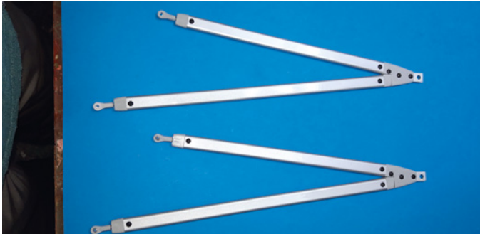
Die Flächenstreben werden später unterhalb des Fahrwerks eingesetzt und per Splint gesichert
