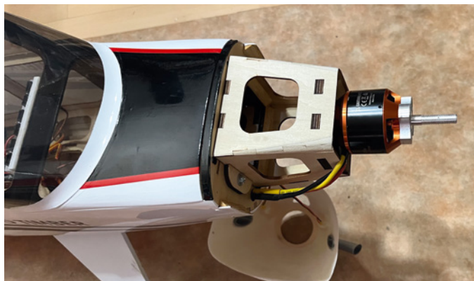
So sieht der Holzmotorträger aus. Leider sind die Einzelteile nur zusammengesteckt und mit Sekundenkleber fixiert. Dieser überbrückt keine Spalte, die aber durch den Winkel entstehen. Weiterhin lassen sich die durch das Lasern verbrannten Klebeflächen schlecht kleben, schon gar nicht mit Sekundenkleber
