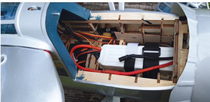
Ein 6s-LiPo mit 4.000 mAh Kapazität ist als Akku vorgesehen und liegt ganz vorne am Brandschott
