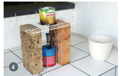
4 Erhitzen der ausgewogenen Bleimenge in einer Konservendose
