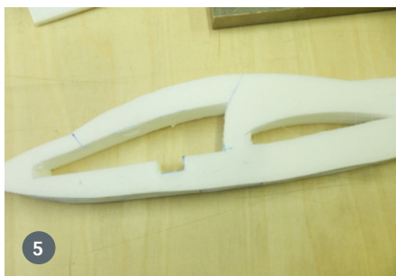
5) Die inneren Lagen wurden nach dem Verkleben für den Einbau der RC-Anlage ausgehöhlt
