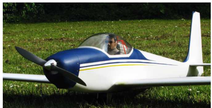
Abbildung 9: Die ASK-14 stammte aus einem recht rudimentären Bausatz eines sehr kleinen Anbieters. Das Höhenleitwerk musste gegenüber dem Plan um gut 30% vergrößert werden, um bessere Flugeigenschaften zu erreichen
