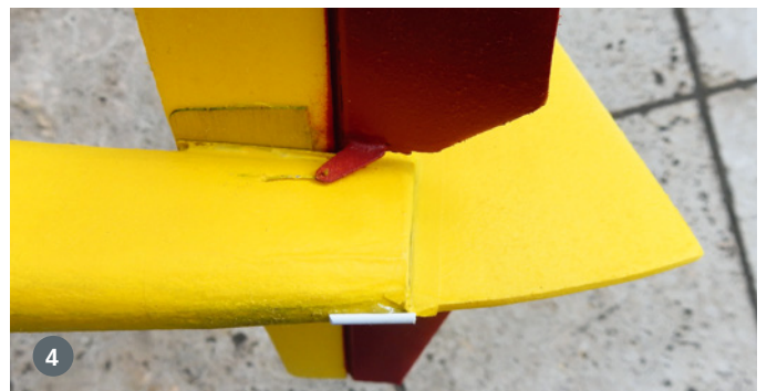
3) Viel Platz ist nicht im Rumpf, aber es reicht für sehr kleine RC-Komponenten gut aus. 4) Der Steuerdraht des Höhenleitwerks ist nur durch Vorspannung gesichert. So fällt die Demontage des Leitwerks leicht. Der kleine Sporn schützt das Seitenruder insbesondere beim Start auf Asphalt
