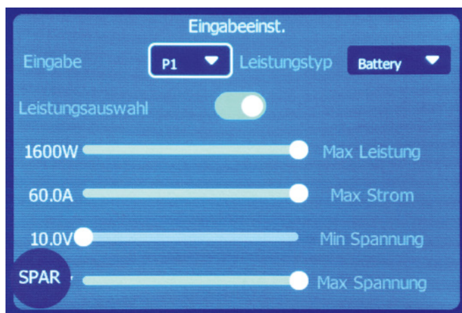
Bei den Grundeinstellungen lassen sich alle relevanten globalen Einstellungen vorgeben, die Parameter für die Versorgungsspannung oder verschiedene Vorgaben für die Sicherheit der Abläufe
