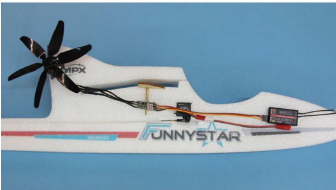
Dem Antriebssatz liegt ein Verlängerungskabel bei, damit der Antriebsakku ganz vorne im Rumpf platziert werden kann
