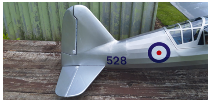
Das Spornfahrwerk ist mit dem Seitenruder verbunden und somit lenkbar
