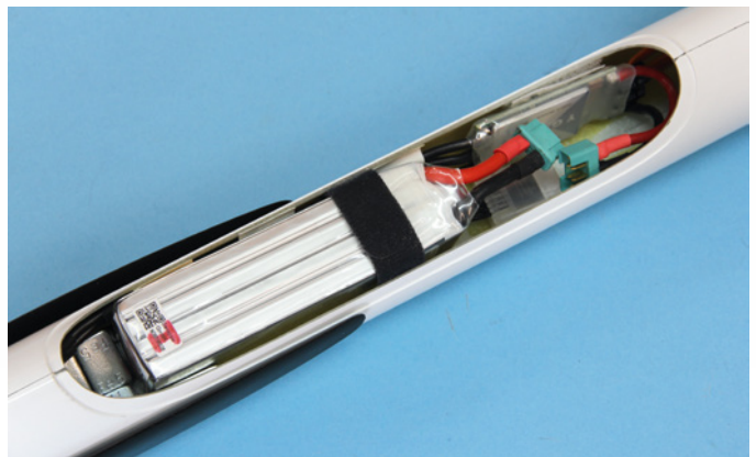
Der 4s-Akku sitzt so weit vorne wie möglich, trotzdem ist noch etwas Trimmblei notwendig
