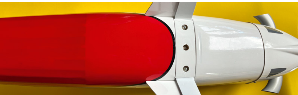
Das findet man nicht bei allen Modellen, für den Übergang am Rumpf im Bereich des Fahrwerks liegt ein passendes Brettchen bei. Für die Befestigung der Finnen am Aluminiumfahrwerk habe ich dünnes 3M-Doppelklebeband verwendet
