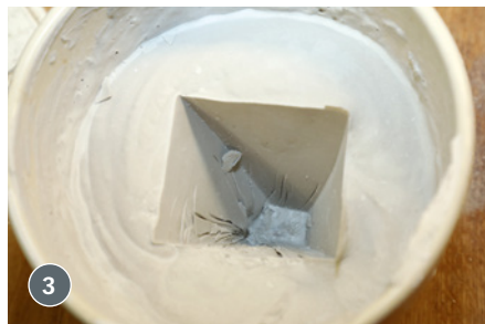
3 Ziemlich exakte Negativform der Rumpfspitze
