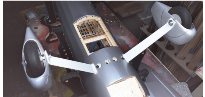
Fahrwerk und Radverkleidungen sind gut vorbereitet und daher schnell angebracht
