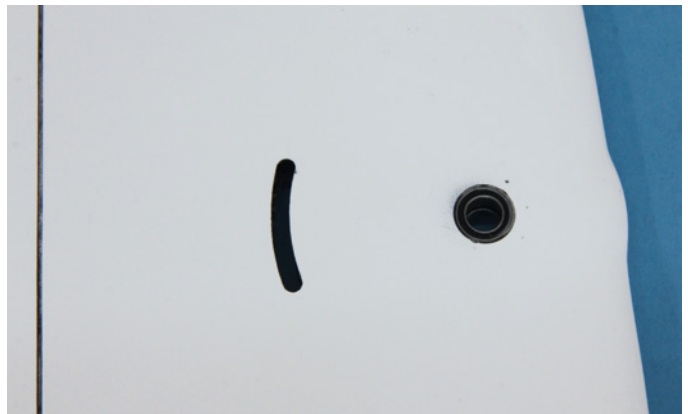
Das Pendel-Höhenruder ist nun beidseitig kugelgelagert
