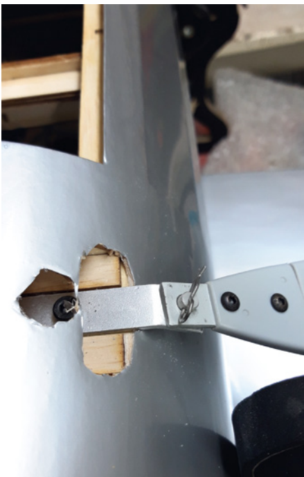
Bei der Position der Befestigungslöcher für die Flächenstreben musste etwas genauer hingeschaut werden. Am Ende fügte sich aber alles und die Montage konnte erfolgen
