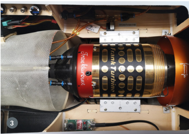
1) Ein Blick auf das Montagebrett für die Elektronikkomponenten. Ganz oben im Bild ist der iGyro zu sehen. 2) Bei abgenommener Radarnase sind alle Akkus gut zugänglich. Zu sehen sind auch die nach vorn geführten Pneumatikschläuche, über die das Bugfahrwerk zum Aufbau am Platz manuell betätigt werden kann. 3) Die Einbausituation der Turbine. Unten im Bild ist der ECU-Konverter von VSpeak zu sehen, der die Turbinendaten für die Telemetrie bereitstellt. 4) Die originalgetreuen Lampen am Bugfahrwerk dienen beim Original als kombinierte Landescheinwerfer und Taxi-Lights. Die Mirage ist hier fertig lackiert, aber noch nicht „geweathert“
