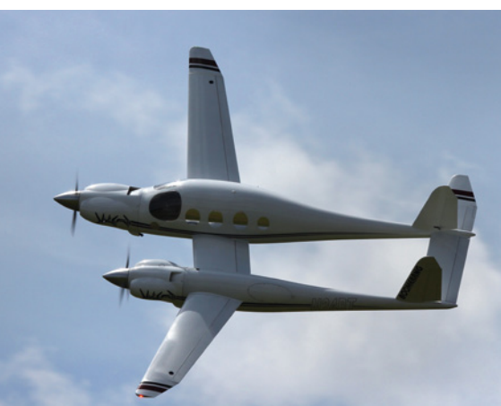
Aus dieser Perspektive ist die asymmetrische Konstruktion der „Boomerang“ des amerikanischen Konstrukteurs Burt Rutan besonders gut zu erkennen. Gerhard Grambow baute das 3.200 mm spannende und 2.850 mm Länge sowie 24,9 kg wiegende Modell
