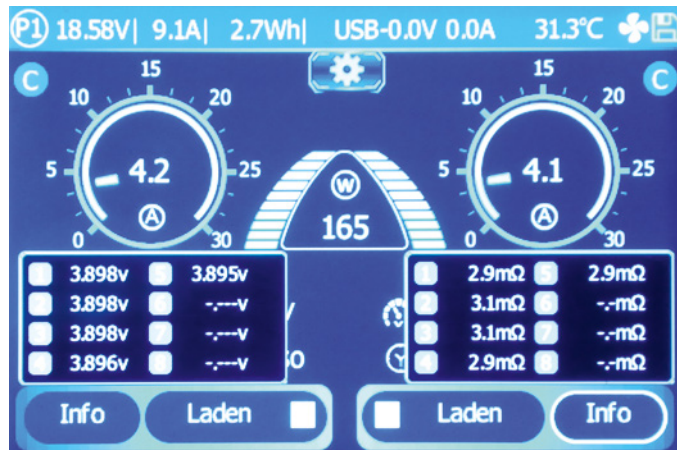
Beim Laden werden die wichtigsten Parameter übersichtlich visualisiert, dazu gehört auch die Anzeige der Innenwiderstände
