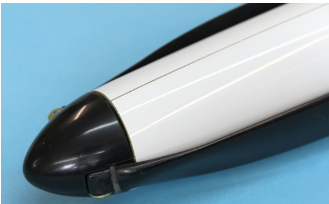
Mit den verwendeten GM- und VM-Spinnern lässt sich ein schöner Rumpfübergang realisieren und die Luftschraubenblätter liegen schön eng an
