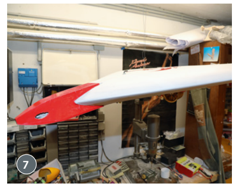
7 Wie gewünscht pendelt das Delta in Schwerpunktlage aus
