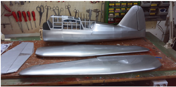
Rumpf, Tragfläche sowie Leitwerk sind mit Silberfolie bespannt und ziemlich leicht
