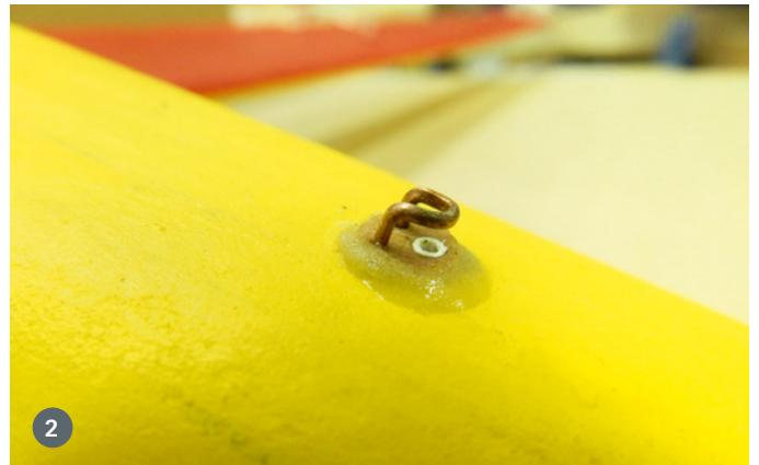
2) Die Schleppkupplung besteht aus einem Bowdenzugrohr und etwas Draht
