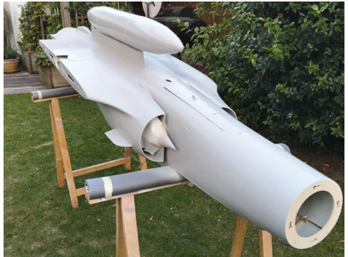
Der erste Gang der Lackierung. Das gesamte Modell wurde hellgrau mit Basislack beschichtet
