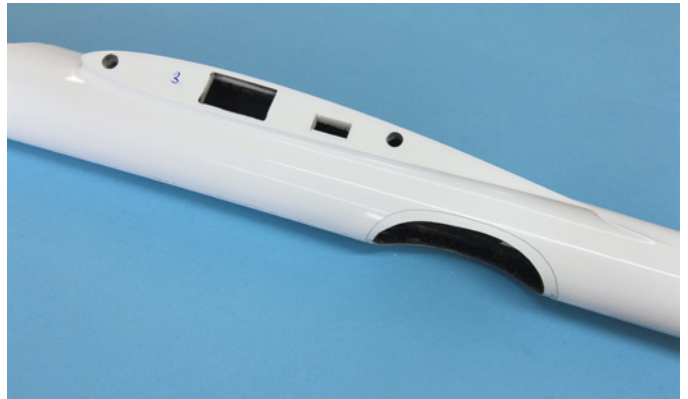
Diese Rumpflücke ist vorgesehen für den Einbau der Rumpfservos. Dadurch ist vorne ausreichend Platz, um einen E-Antrieb unterzubringen
