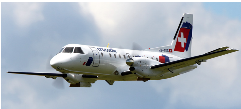
Eine SAAB 340B in den Farben der Crossair. Kim Contento hatte neben seiner Dash 8 auch diese Zweimot mit 3.400 mm Spannweite, 2.700 mm Länge und einem Gewicht von 20 kg nach Oppingen gebracht
