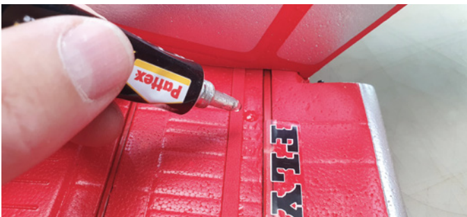
Der Schwerpunkt kann ruhig noch 4 mm weiter zurück als die Anleitung es vorschlägt. Der erflogene Favoritenwert wird fühlbar mit einem Tropfen Kleber markiert
