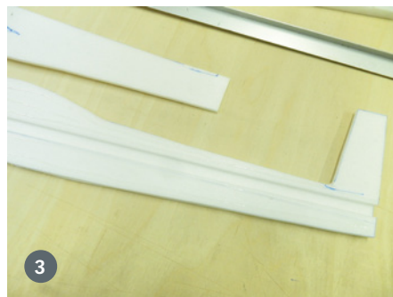
3) Im Heck wurde das Depron ausgespart, um Gewicht zu sparen und den Einbau der Anlenkungen zu vereinfachen
