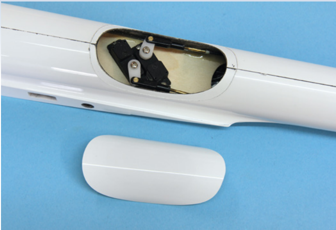
Auf diesem Bild sitzt das Servobrett für die Rumpfservos bereits an Ort und Stelle
