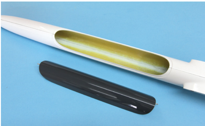
Der Rumpf ist im vorderen Bereich CFK-frei und mit Kevlar verstärkt
