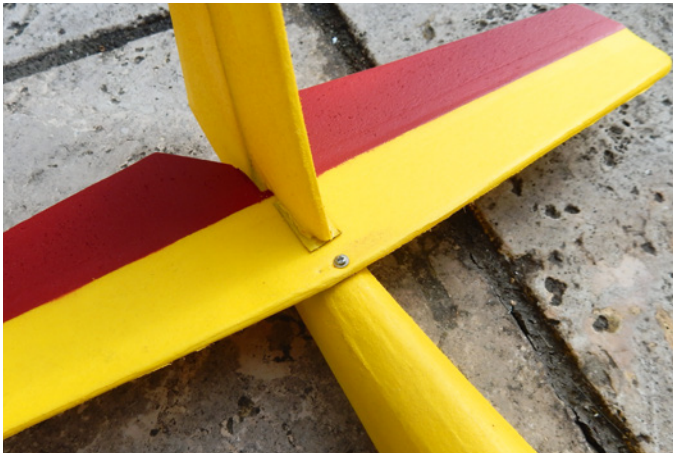
Zum Demontieren des Höhenleitwerks muss nur diese kleine Schraube gelöst werden
