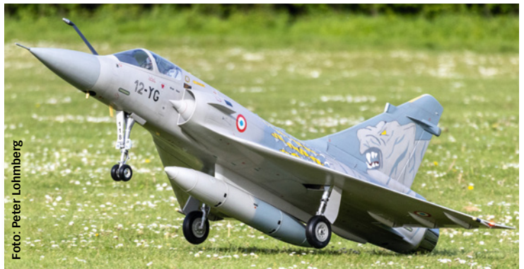
Beim Erstflug hob die Mirage ruckartig ab und die Nozzle berührt das Gras, die Wirkung der Starthilfe musste noch erhöht werden
