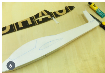
6) Nach dem Aufkleben der äußeren Schicht sieht der Rumpf schon fast wie ein Modell aus
