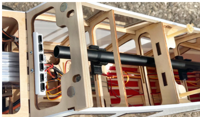
Damit man das Steckrohr nicht zuhause vergisst, baue ich mir bei den meisten Modellen eine gedruckte Halterung ins Modell. Diese wiegt lediglich 10 g und man kann das Steckrohr einclippen
