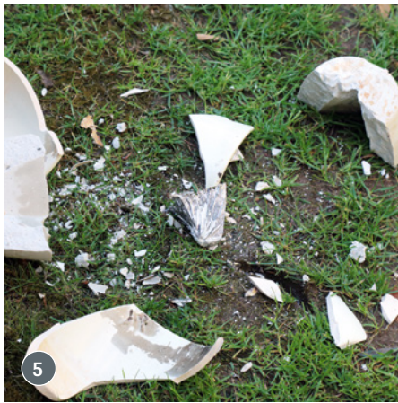
5 Zum Entformen muss der Topf zerstört werden
