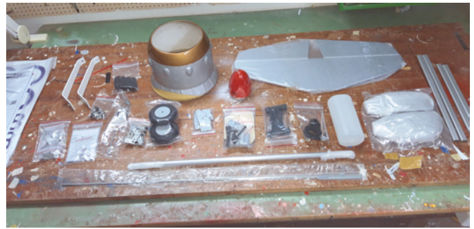
Zahlreiche Teile wie Räder, Fahrwerk oder Ruderhörner sind im Bausatz bereits enthalten
