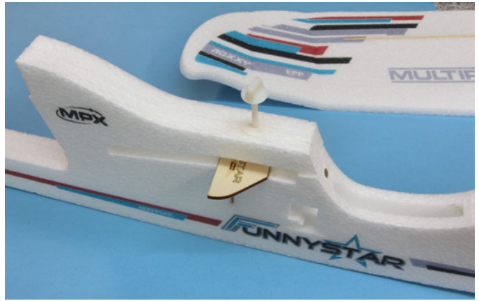
Die Fläche lässt sich durch Lösen einer Kunststoffschraube abnehmen und macht den FunnyStar transportfreundlich
