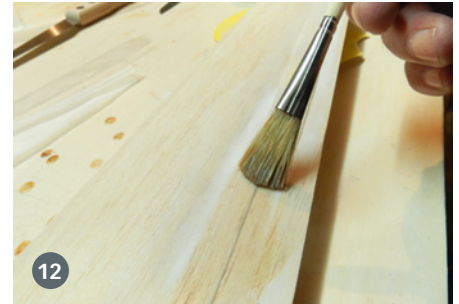
10) Zum Einkleben des Flächenverbinders wird das Mittelstück mit viel Klebeband mit den Flügelhälften verbunden und für die richtige V-Form unterlegt. 11) Die Querruder werden ausgeschnitten. 12) Auf der Oberseite werden dünne Vliesscharniere angeschlagen
