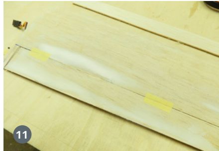
10) Zum Einkleben des Flächenverbinders wird das Mittelstück mit viel Klebeband mit den Flügelhälften verbunden und für die richtige V-Form unterlegt. 11) Die Querruder werden ausgeschnitten. 12) Auf der Oberseite werden dünne Vliesscharniere angeschlagen
