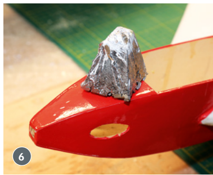
6 Die Bleiform lässt sich prima in der Spitze platzieren
