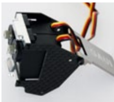
Die Rollservos sitzen im vorderen Chassisteil
