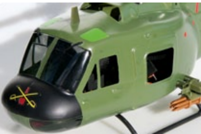
Die großen Cockpitscheiben sind verglast, während die seitlichen Fenster zwecks besserer Kühlung offen sind. Auch das Kufenlandegestell wurde vorbildgetreu gestaltet
