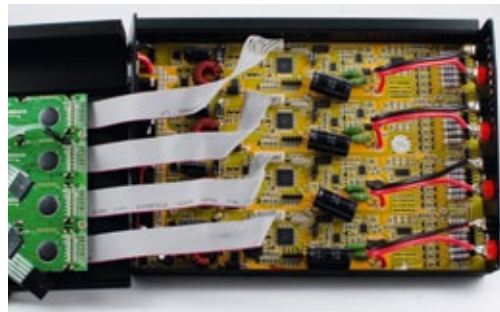
Innenansicht des Ladegeräts. Aufgeräumte Platine und getrennt aufgebaute Ladeausgänge mit der Display/Bedien-Platine auf der linken Seite
