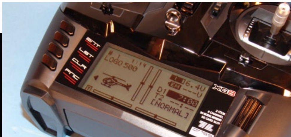
Die Programmieringabe erfolgt über vier Tasten (links) und dem intuitiv bedienbaren Dreh/Drück-Zylinder (rechts)
