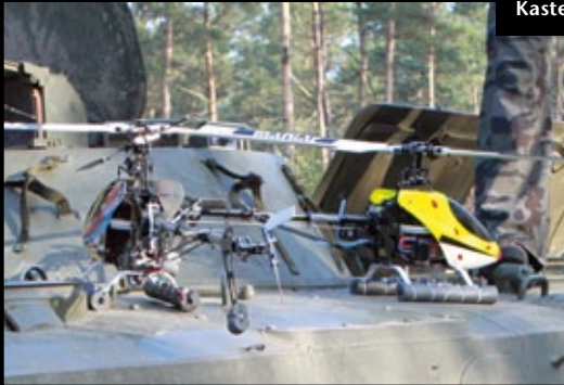
Die Hubschrauber des Tages: Zwei T-Rex 500 von freakware, angetrieben mit 6s-LiPos. Die Flybarless-Version wird durch ein microBeast stabilisiert
