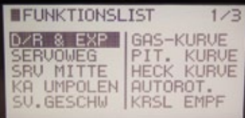
In der Funktions-Liste sind auf drei Seiten all die Menüs aufgeführt, mit denen Modellspeicher-spezifisch gearbeitet wird
