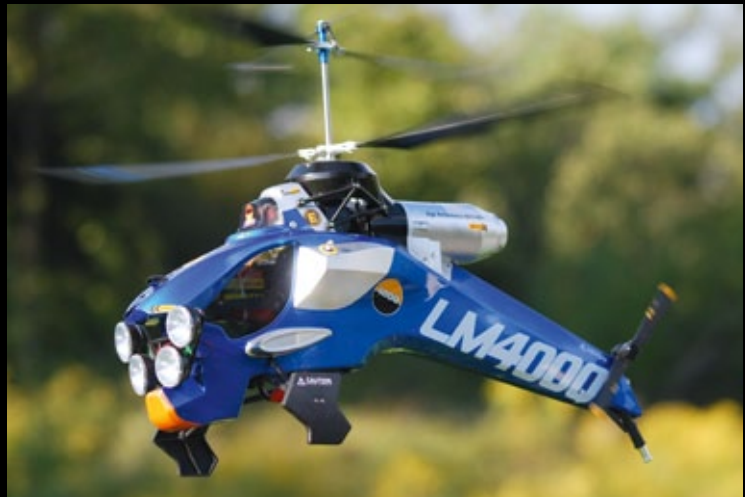
Koaxhelis mit ihren beiden gegenläufigen Hauptrotoren weisen eine beeindruckende Flugruhe auf, die jedoch beim Outdoor-Einsatz auf ihre Grenzen stößt (siehe Text)
