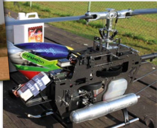
Über dem Spektrum-Empfänger sitzt die Flybarless-Elektronik, bei der es sich im Prinzip um ein microbeast handelt, das jedoch speziell für TSA gelabelt ist
