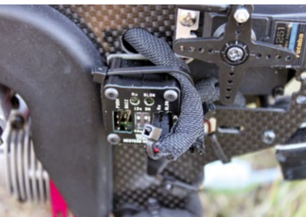
Der im TT X50 verbaute Centurion Remote Glow Driver kann mit bis zu 18 Volt betrieben werden und die Vorglühzeit ist zwischen 12 und 40 Sekunden wählbar
