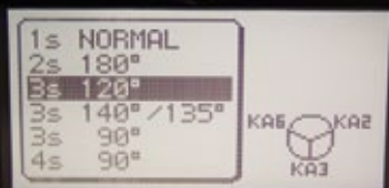
Bei Auswahl des Taumelscheiben-Typs wird gleich die Position der Servos an den Empfängerausgängen mit angezeigt
