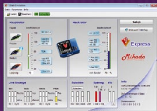
Nach Installation der V-Stabi-Software sowie des USB-Treibers öffnet sich dieser Startbildschirm zur Programmierung des Mini-V-Bar
