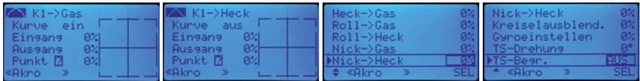
Alle weiteren Mischer im Menü Helikopter mix müssen auf Null-Werte gesetzt werden
