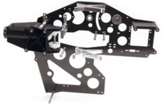
In der Ansicht des Chassis ohne rechtes Seitenteil wird der konstruktive Aufbau des G4 mit seinen Alu- und Kunststoff-Lagerböcken deutlich
