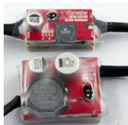
Das Hercules Super BEC und Hercules Mini BEC im Größenvergleich. Für Anwendungen bis 6s ist das Mini BEC die günstigere Alternative
