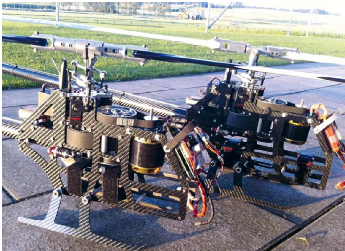
Die beiden ersten Prototypen des Banshee, zu Testzwecken noch mit unterschiedlichen Controllern und Motoren (5035 und 4525) bestückt
