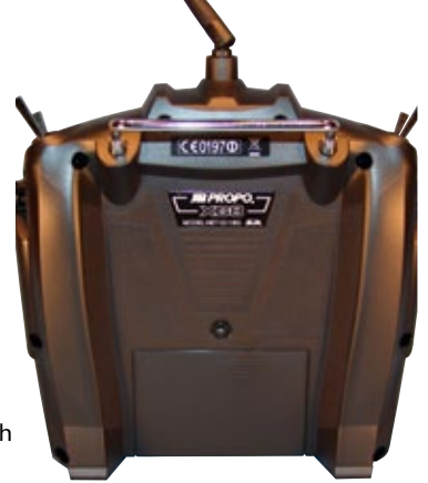
Die übertiefe Griffmulde auf der Rückseite lässt das Gerät super in der Hand liegen. In der Mitte die Lehrer-Schüler-Buchse. Die Funktionen können einzeln übergeben werden
