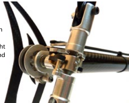
Das Heckgetriebe ist mit einer sehr kurzen Heckwelle versehen, um auch hier das Moment so klein wie möglich zu halten. Die hohe Übersetzung (= hohe Heckrotordrehzahl) sorgt in Verbindung mit dem microbeast für sehr gute Performance – und das auch bei relativ kleinen Heckrotorausschlägen
