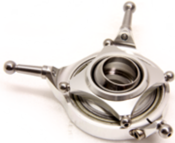
Die Ganzmetall-Taumelscheibe mit 135-Grad-Anlenkung und einstellbarem Spiel des Kugellagers
