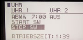
Das Uhrenmenü bietet zwei Uhren an. Jede kann individuell konfiguriert werden, zum Beispiel als abwärts zählende Stoppuhr. Die Schalterwahl ist völlig frei
