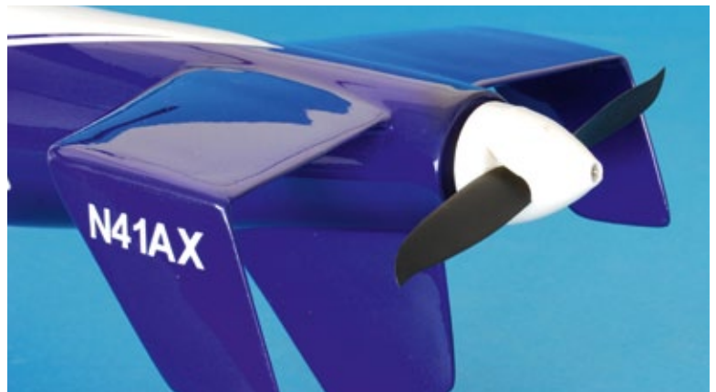
In der Grundausstattung ist das Propeller-Spinner-System ohne Funktion und dient nur der vorbildgetreuen Optik. Ein optionales Antriebsset gibt es bei Skyrush im Tuning-Sortiment
