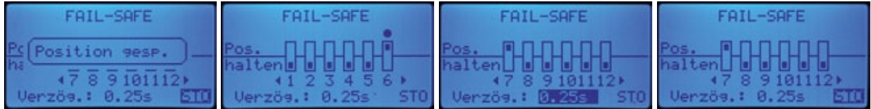
Im Failsafe-Menü werden nur der K6 für Motor-Aus auf Position und alle übrigen Kanäle auf Hold gesetzt. Nach Auswahl eines von drei Zeitfenstern wird die Position des Drehzahlvorgabereglers 6 (Motor aus) im Empfänger abgespeichert
