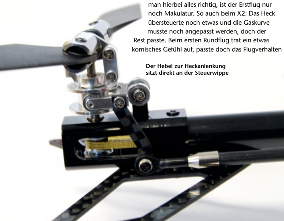
Obere und untere Hälfte des dreiteiligen Chassis sind über Distanzbolzen verbunden
