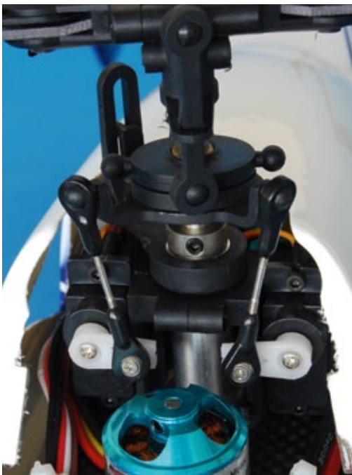
Ab Werk sind die Servos für Nick und Roll, die am Hauptrahmen befestigt sind, mit der Taumelscheibe verbunden
