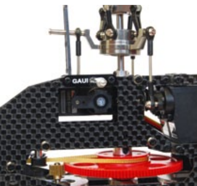
Dort, wo der Gauji-Schriftzug zu sehen ist, liegt eine Platte aus Alu über dem dünnen Steg des CFK-Chassis
