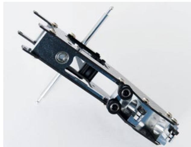
Gerade so schmal wie nötig. Hier der Chassisrücken von unten
