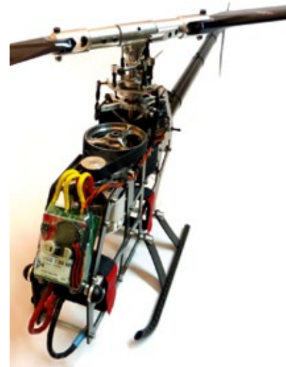
Frontseitig angeordnet ist der Controller, der auf kürzestem Weg mit den Motoranschlusskabeln verbunden ist
