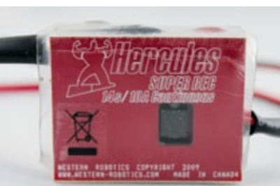
Das Hercules Super BEC bietet 10 A Dauerleistung an bis zu 14s und ist bis 9 Volt einstellbar
