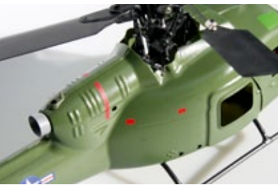
Die großen Cockpitscheiben sind verglast, während die seitlichen Fenster zwecks besserer Kühlung offen sind. Auch das Kufenlandegestell wurde vorbildgetreu gestaltet
