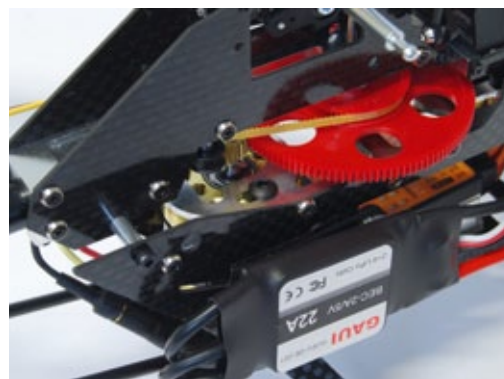
Obere und untere Hälfte des dreiteiligen Chassis sind über Distanzbolzen verbunden
