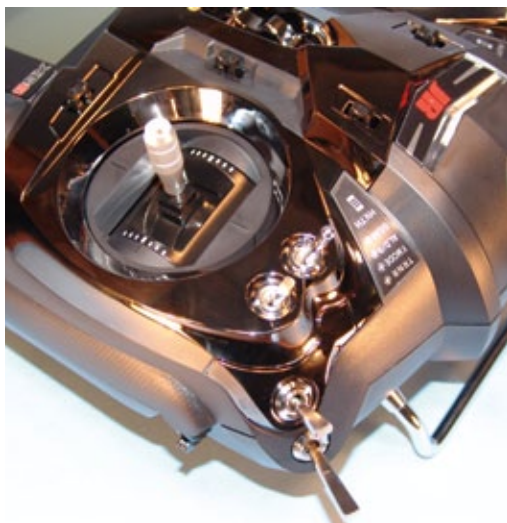
Stirnseitig rechts liegt ein Momentschalter mit langem Griff; er bietet sich für den Lehrer-Schüler-Betrieb an
