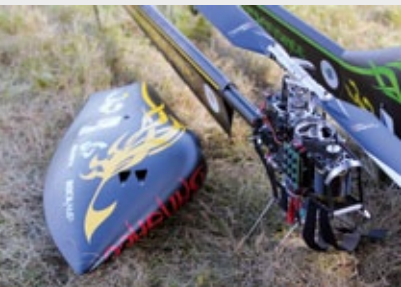
Auch der Heckausleger bekam eine superleichte, aerodynamische Vollverkleidung, deren Profilschnitt hier gut erkennbar ist
