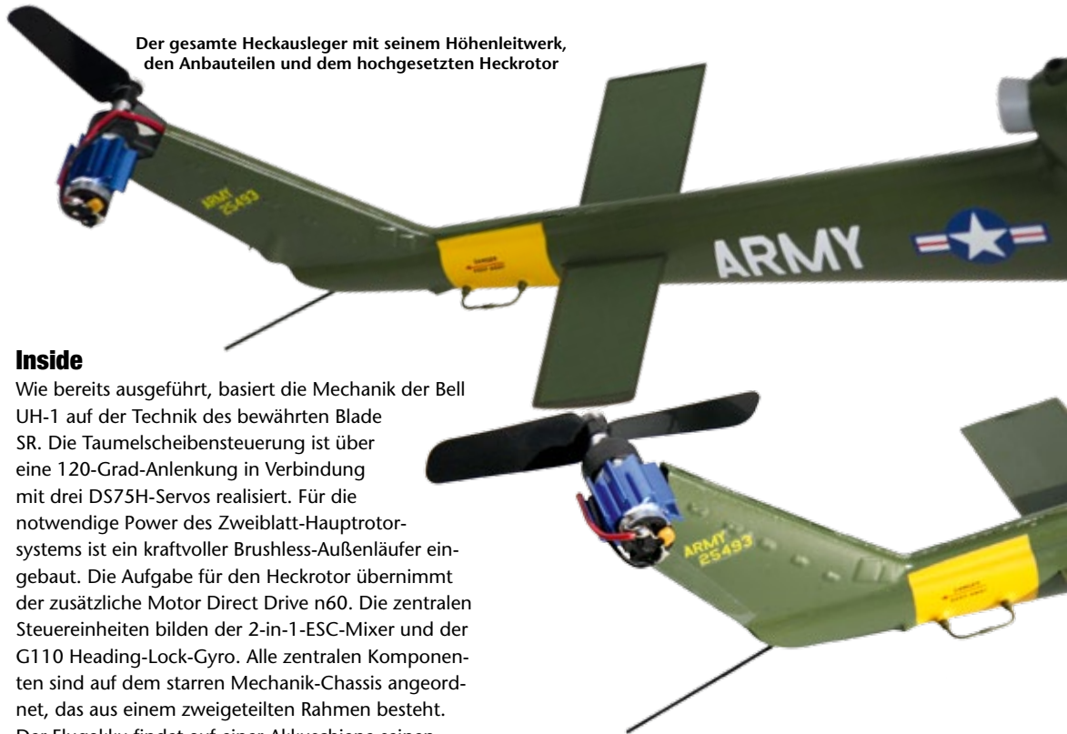
Die Hochachsensteuerung erfolgt über einen gesonderten Heckmotor, der mit einer Luftschaube versehen ist. Der Sonderkühlkörper beugt eventuellen Überhitzungen vor
