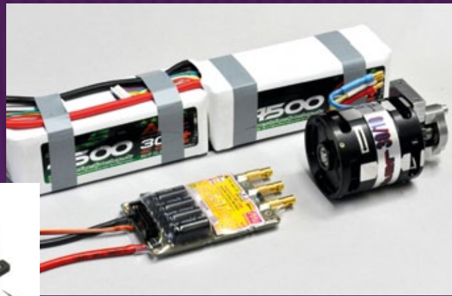
Ein Copter 30-10, ein BL-Controller future-I-40/100 mit exzellentem Governor-Mode und ein SLS 12s/4.500 mAh LiPo-Akku verleihen dem Rigid Flügel
