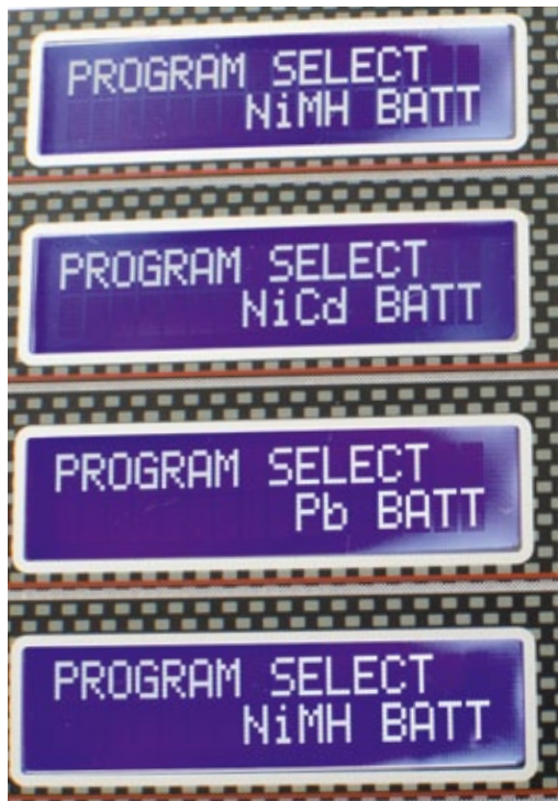
Verschiedene Akkutypen können getrennt voneinander pro Ladeausgang eingestellt werden
