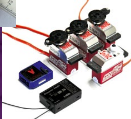
Vier MKS-BL-Hochvolt-Servos, ein Mini-V-Bar von Mikado und der GR-24-Empfänger bilden den Hauptteil der elektronischen Ausstattung
