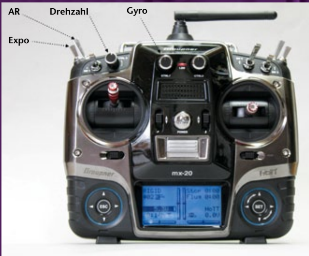
Funktionsbelegung der Schalter beziehungsweise Drehregler bei unserer mx-20
