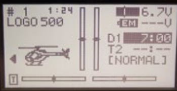
Startbildschirm: Neben den beiden Timern wird die Spannung des Sender- und Empfängerakkus angezeigt (natürlich nur bei eingeschaltetem Empfänger)
