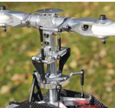
Oben das robuste, schrägverzahnte Hauptzahnrad, darunter das gesonderte Zahnrad für den Heckantrieb
