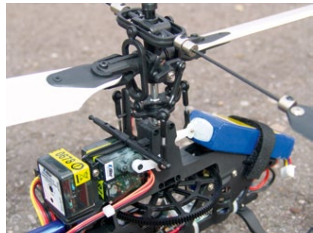
Der Hauptrotor mit seiner axial verschiebbaren Stabieinheit, womit sich die Verwendung eines herkömmlichen Pitchkompensators erübrigt. Die Bell-Hiller-Mischhebel sitzen an den Blattverstellhebeln
