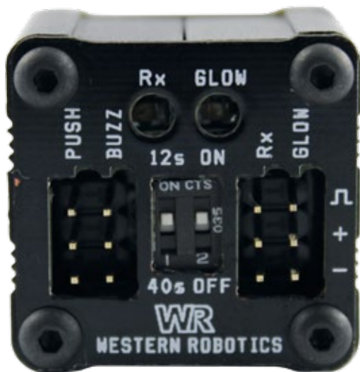
Der Centurion Remote Glow Driver ermöglicht komfortables Vorglühen der Glühkerze vom Sender aus
