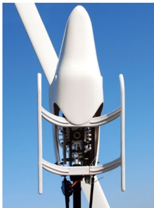
Die Haube ist recht passgenau und umschließt den vorderen Kufenbügel teilweise
