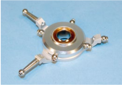
Die neue 140-Grad-Taumelscheibe ist komplett aus Metall gefertigt. Das Chassis lässt alternativ auch eine 90-Grad-Anlenkung zu
