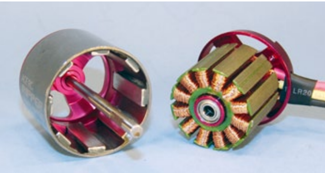
Der bürstenlose Außenläufermotor ist achtpolig und hat eine spezifische Drehzahl von 1.150 Umdrehungen pro Minute und Volt
