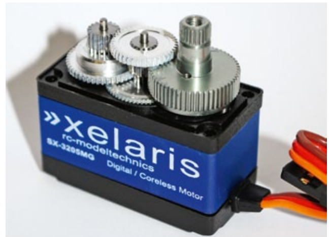
Auch das mitgelieferte Heckrotorservo macht einen spielfreien und robusten Eindruck
