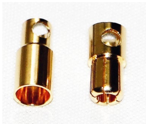
mylipo mit 6 Millimeter. Sie sind sehr hochwertig verarbeitet, kurz gebaut, haben geschlitzte Kontaktflächen und einen sehr niedrigen Übergangswiderstand
