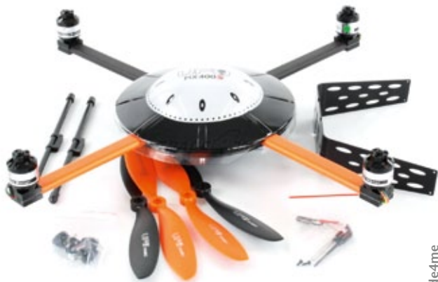
Der neue, auf Kunstflug getrimmte MX400S hat Zweiblattrotoren und eine entsprechend angepasste Elektronik
