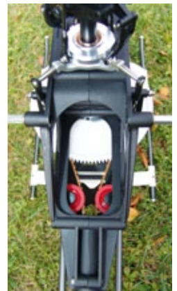
Der Arbeitsplatz des Antriebsmotors. Sein Ritzel greift in das Hauptzahnrad zwischen dem nach hinten zum Heck laufenden Riemenantrieb
