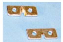
Modifikation: Die Servo-Befestigungsplättchen wurden mittig ausgefeilt, um ein Aufsetzen auf der Rippe am Servoflansch zu vermeiden
