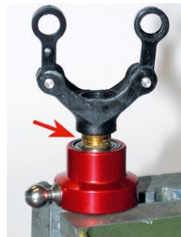
Die Schiebepülse des Heckrotors musste vor dem Einbau teilweise zerlegt und von Spänen gereinigt werden
