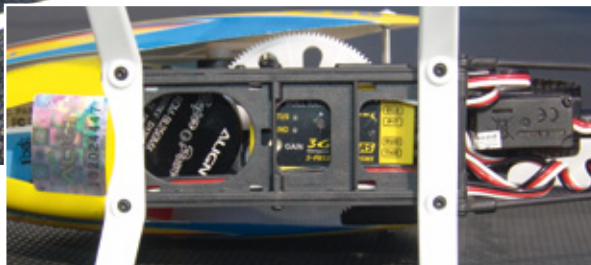
Durch die untere Lagerleiste lässt sich das 3GX MRS bedienen. Über der Aufschrift „3G“ ist der Programmier-Button, daneben sind die beiden LED
