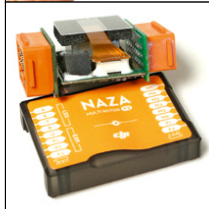
Viel Elektronik und Sensorik auf wenig Raum. Doch das Geheimnis der Leistungsfähigkeit des Systems liegt in einer ausgeklügelten Firmware, die die Signale der in einem gedämpften Metallblock untergebrachten Sensorik in Steuerbefehle für den Multikopter umrechnet
