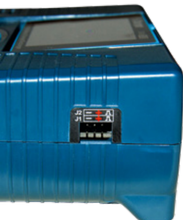
An der rechten Seite sitzen die Anschlüsse für den Servotest (J1) und zur Einspeisung einer lastfesten externen Spannung (J2 6,0 bis 8,4 V empfohlen) bis zur maximalen Spannungshöhe der jeweils angeschlossenen Servos
