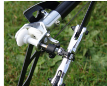
Der Heckrotor läuft mit seiner Spiralverzahnung sehr leise und wird trotz Leichtbau allen mechanisch Belastungen gerecht
