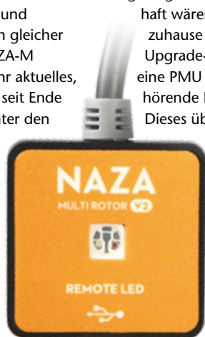
Wie NAZA-H (Helikopter-Variante von NAZA) verfügt nun auch NAZA-M2 über eine separate Status-LED. An ihrer Stirnseite befindet sich ein Mikro-USB-Anschluss zur Kommunikation mit einem PC
