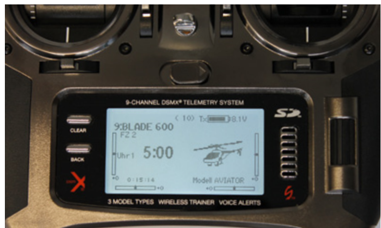
Zwei Taster und ein Rolldrucktaster (rechts) dienen zum Navigieren durchs Menü
