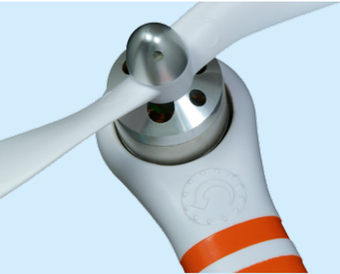
Handelsübliche Befestigung der Luftschrauben über Spinner am Walkera QR X350. Die Drehrichtungen sind markiert
