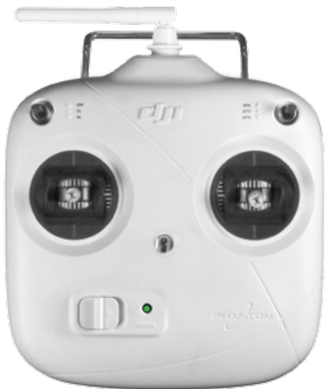
Zum Set gehört der weiße DJI-Sender, der über einen neutralisierenden Gasknüppel verfügt
