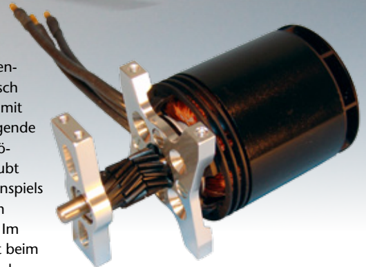
Motorträger und Gegenlager bilden keine Einheit. Deshalb Vorsicht, um beim Einbau die Motorwelle nicht zu verspannen
