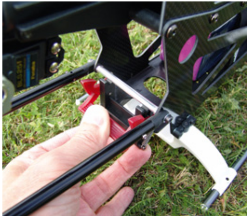
Die Verriegelung des Antriebsakkus lässt sich bequem mit einem Handgriff lösen
