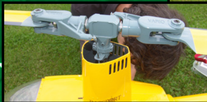
Aus Vario-Serienteilen sind Haupt- und Heckrotor der Robinson aufgebaut
