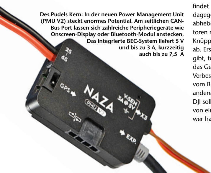
Wie NAZA-H (Helikopter-Variante von NAZA) verfügt nun auch NAZA-M2 über eine separate Status-LED. An ihrer Stirnseite befindet sich ein Mikro-USB-Anschluss zur Kommunikation mit einem PC
