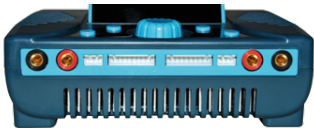
An der Frontseite befinden sich die Anschlüsse für die Akkus, Balancer und gegebenenfalls Temperaturfühler
