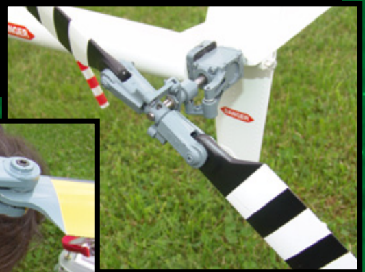
Aus Vario-Serienteilen sind Haupt- und Heckrotor der Robinson aufgebaut
