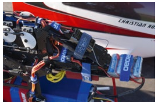
Ein zusätzlicher, vierzelliger Eneloop-Stütz Akku sitzt ganz vorne, das Heckrotor-Gyro-System ist ein Futaba GY-701
