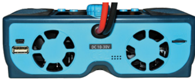
Zwei temperaturgesteuerte Lüfter saugen die Abwärme an der Rückseite aus dem Innenraum. Links sieht man zwei USB-Anschlüsse (Standard und Mini), und in den Slot rechts kann eine Micro-SD Karte eingesteckt werden
