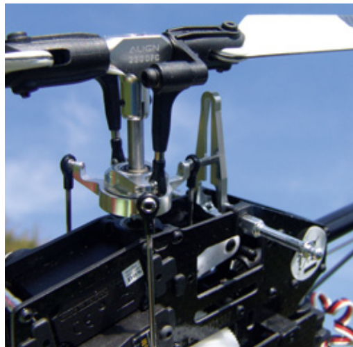
Der Heckrotor mit seiner kugelgelagerten Doppelanlenkung
