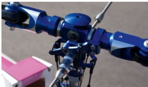
Als reinrassige F3C-Wettbewerbsmaschine ausgelegt, besitzt der Hirobo-Hauptrotor klassische Stabilisierungsstangen
