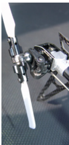
Der Heckrotor mit seiner kugelgelagerten Doppelanlenkung
