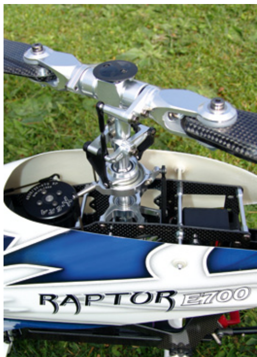
Der Hauptrotorkopf des E700 ist eine mechanische Augenweide. Die Mitnehmer reduzieren den Weg, der von der Taumelscheibe eingesteuert wird
