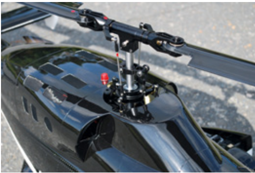
Der fertige Rotormast mit sauber abgelängten Gestängen
