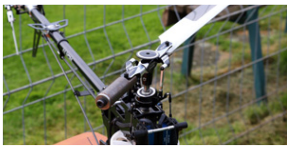
Klaus Heymann stellte seinen T-Rex 550E in der Einblatt-Variante vor. In den 1990er-Jahren war Günter Knipprath aus Aachen (Peka Lufttechnik) der erste, der diese außergewöhnliche Rotorkonstruktion mit nur einem Hauptrotorblatt umsetzte und auch erfolgreich vorflog. Das Geheimnis, dass es funktioniert, ist nichts anderes als Massenausgleich – hier in Form eines entsprechenden im Blatthalter eingesetzten Gegengewichts. Erstaunt waren wir bei Klaus Heymann darüber, dass er mit seinem Modell auch Rollen und Loopings flog. Etwas seltsam war allerdings das Blattgeräusch
