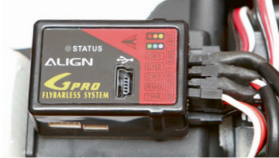
Auf der Oberseite findet sich ein mini-USB-Anschluss zur Verbindung mit dem PC, die Status-LED leuchtet im Betrieb grün (Gyro im Heading-Lock Mode) oder rot (Gyro im Normal-Mode). Die vom 3GX bekannten Potis und LED sind der Programmierung per Software gewichen
