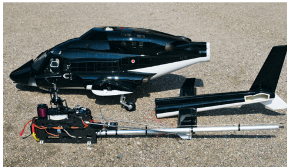
Die vorbereitete Mechanik ist bereit zum Einsetzen in den Rumpf. Bei diesem Arbeitsschritt wird gleichzeitig auch das Heckteil montiert und mit dem Rumpf verschraubt
