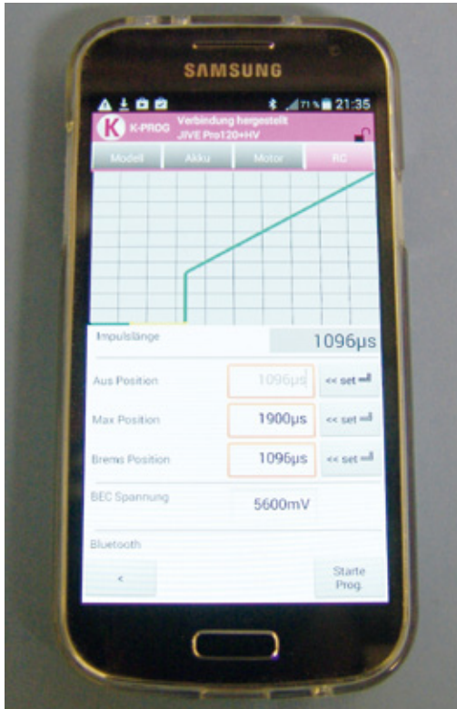
Hier sehen wir die Steuerkennlinie des JIVE Pro in Abhängigkeit von der anliegenden Impulslänge. Links Motor aus, Bail Out und Vollgas-Stellung ganz rechts
