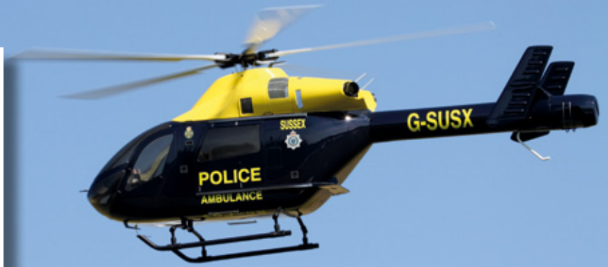
Ein weiterer NOTAR-Helikopter – die MD 902 Explorer von Vario Helicopter, vorgeführt von Peter Holtackers. Key-Features: Maßstab 1:6, Elektro-Power-Version mit Kontronik Pyro 700-52 in Kombination mit einem Jive, Rotordurchmesser 1.500 und eine Länge von 1.660 Millimeter und Abfluggewicht 8,2 Kilogramm
