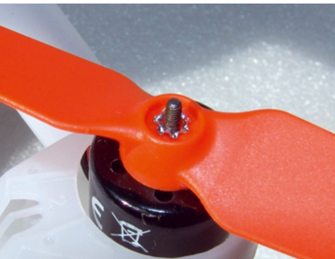
Vor dem Aufsetzen der Muttern dürfen keinesfalls die Sicherungsscheiben vergessen werden
