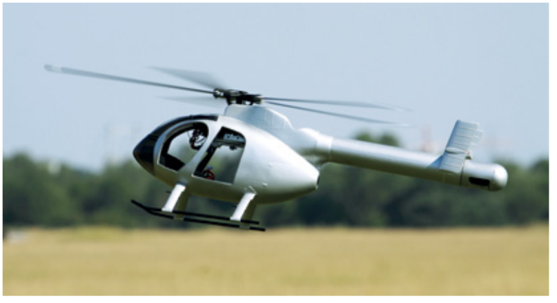
Hier fehlt doch was? Nein, es hat seine Richtigkeit, dass dieses Modell in 450er-Größe keinen Heckrotor hat. Die Hochachsen-Steuerung erfolgt über ein NOTAR-System (NOTAR steht für „no tail rotor“), bei dem ein über einen Axiallüfter generierter Luftstrom durch den Heckausleger auf eine drehbare Steuertüte am Heck gelenkt wird
