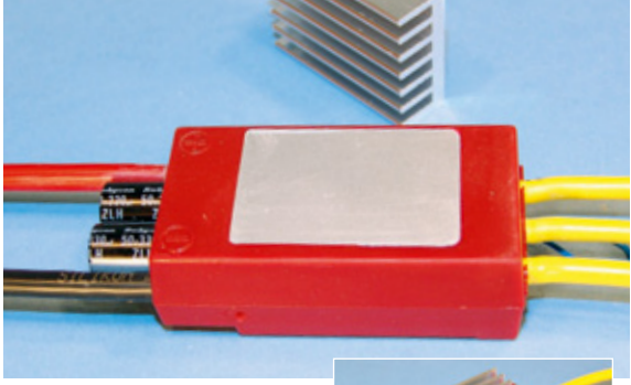
Der mitgelieferte Kühlkörper kann bei Bedarf auf die Wärmesenke der darunter liegenden Leistungstransistoren geklebt werden und erhöht die Strombelastbarkeit
