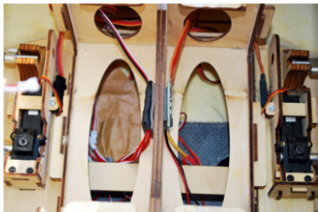
Die beiden Hauptfahrwerks-Motoren von oben. Der Rumpf ist so geräumig, dass sie gut zugänglich sind. Im unteren Spantengerüst befinden sich diverse Versorgungsleitungen. Außerdem erkennt man die Beleuchtungselektronik (links), daneben ist der elektronische Schalter für das Instrumentenpanel
