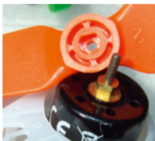
Die Flachstellen der Luftschraubenaufnahme und der Motorwelle sorgen für kraftschlüssige Mitnahme
