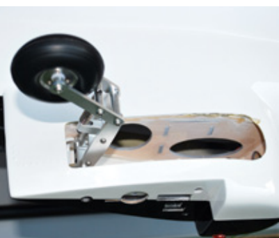
Für die Fahrwerksmotoren sind kleine Rahmen im Rumpf vorhanden. In diese werden sie eingesetzt, mit zwei Schraubchen fixiert und mit einer Querlasche verklemt. Der Abtriebshebel des Motors ist höhenverstellbar. Dadurch kann der Weg vergrößert oder verkleinert werden
