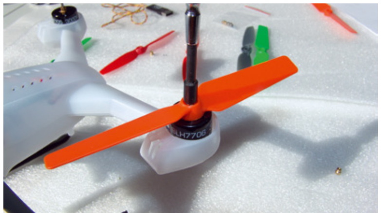
Gefühlsvolles Anziehen der Muttern ist angesagt – die Gewindebolzen der Motorwelle sind nur 1,8 Millimeter stark
