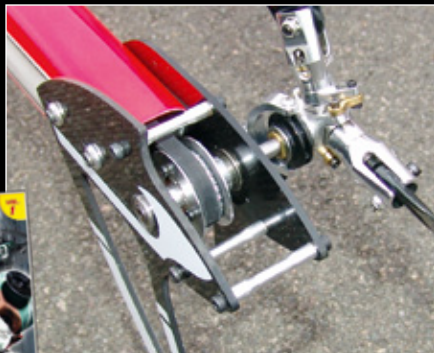
Detail des Urukay-Heckgetriebes mit dem zwischen CFK-Seitenplatten gelagerten Alu-Riemenrad. Mit Hilfe von in den Platten angebrachten Langlöchern kann die Riemen Spannung eingestellt werden
