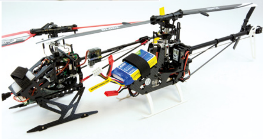
Vergleich: Links im Bild der seinerzeit mit vielen Tuningteilen gepimpte Blade 130 X mit den markanten Linear-Servos, rechts der geringfügig größere Blade 180 CFX. Letzterer überzeugt ohne jegliche Tuningmaßnahmen schon im Serienzustand und dürfte auch Hardcore-3D-Fans zufrieden stellen
