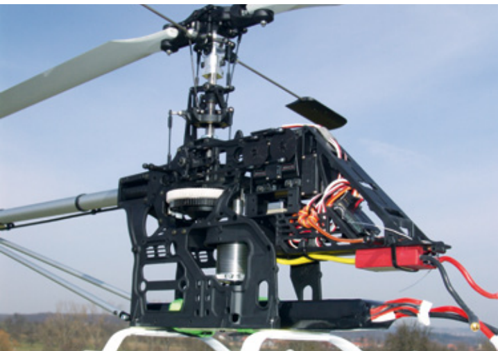
Vor jedem Start ist die Mechanik einem ausführlichen Vorflug-Sichtcheck zu unterziehen (siehe Text)
