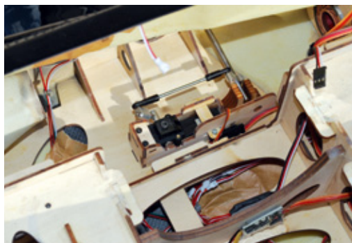
Für die Fahrwerksmotoren sind kleine Rahmen im Rumpf vorhanden. In diese werden sie eingesetzt, mit zwei Schraubchen fixiert und mit einer Querlasche verklemt. Der Abtriebshebel des Motors ist höhenverstellbar. Dadurch kann der Weg vergrößert oder verkleinert werden
