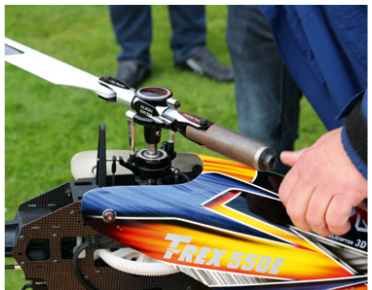
Klaus Heymann stellte seinen T-Rex 550E in der Einblatt-Variante vor. In den 1990er-Jahren war Günter Knipprath aus Aachen (Peka Lufttechnik) der erste, der diese außergewöhnliche Rotorkonstruktion mit nur einem Hauptrotorblatt umsetzte und auch erfolgreich vorflog. Das Geheimnis, dass es funktioniert, ist nichts anderes als Massenausgleich – hier in Form eines entsprechenden im Blatthalter eingesetzten Gegengewichts. Erstaunt waren wir bei Klaus Heymann darüber, dass er mit seinem Modell auch Rollen und Loopings flog. Etwas seltsam war allerdings das Blattgeräusch
