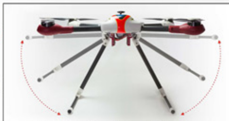
Durch die extrem leise einziehbaren Kufen wird bei Verwendung eines Gimbal's eine störungsfreie Sicht durch die Kamera ermöglicht.
