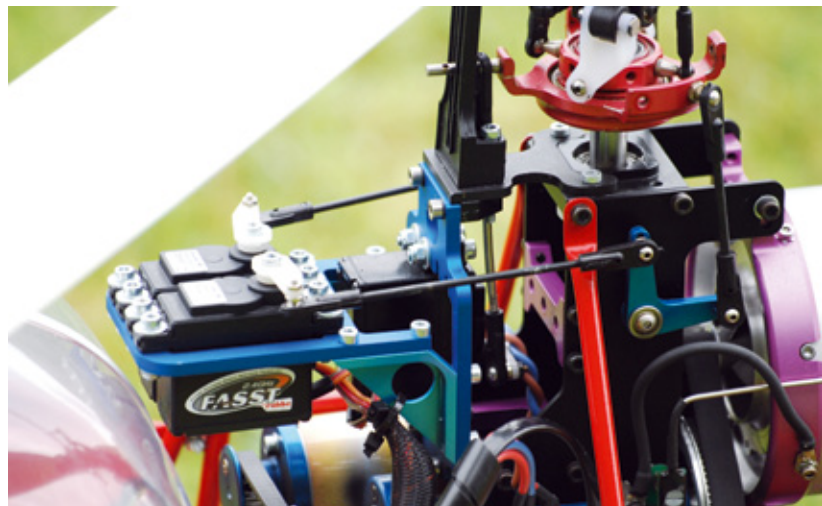
Zum Check gehört auch die Überprüfung sämtlicher Kugelgelenke/Anlenkungen
