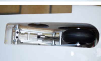
Funktionstest des Hauptfahrwerks, das sauber eingestellt werden muss
