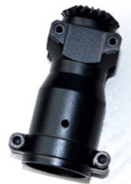
Um Axialspiel herauszunehmen, wurde das Ritzel des Heckrotors in die Lager eingeklebt
