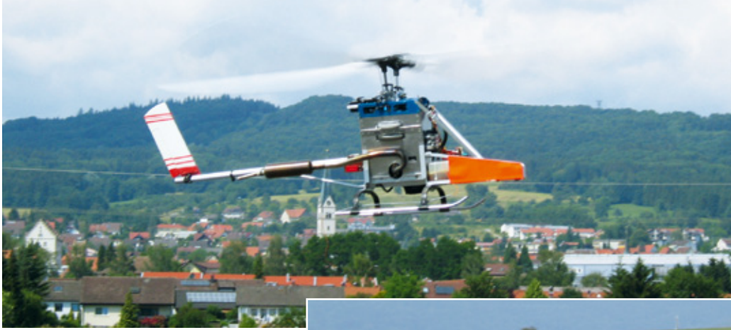
Abbildung 1: Testbed (ohne Höhenleitwerk). Daten: Rumpflänge 1.700 mm, Rotordurchmesser 2 x 1.520 mm, Antriebsmotor: Benzin 23 ccm, Abflugmasse: 6.500 g
