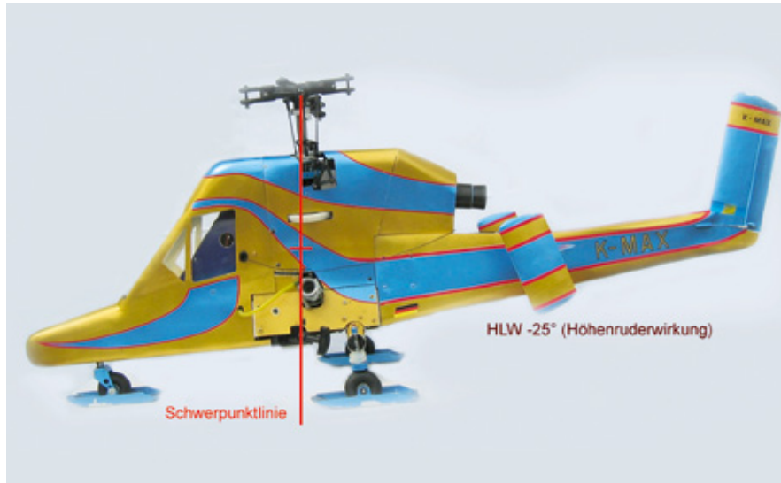
Abbildung 8: K-MAX Brustschwimmer – Steiler Landeanflug und Autorotation. Die Antriebsleistung und damit auch das inhärente Auf-Nick-Moment gehen gegen Null (rot: Schwerpunktlinie). Durch reduziertes beziehungsweise zu Null gewordenen inhärenten Nickmoment wird das auftretende Ab-Nick-Moment durch Höhenleitwerkstellung von bis zu circa -25^\circ (Höhenruderwirkung) kompensiert. Um die Wirkung des HLW zu erhalten, ist eine ausreichend hohe Vorwärtsgeschwindigkeit notwendig.
