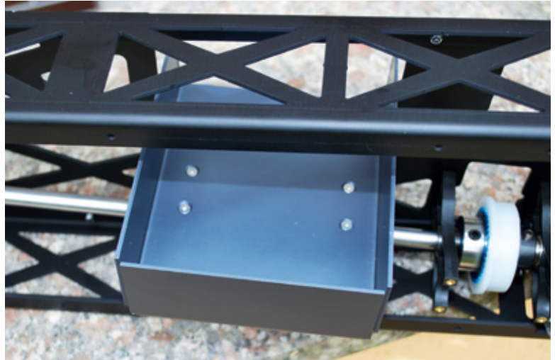
Der Akku-Aufnahmekasten besteht aus eloxiertem Alu
