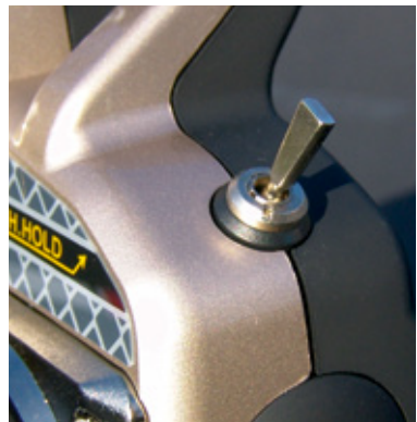
... rechts der Autorotationschalter, der bei Aktivierung den Motor stoppt
