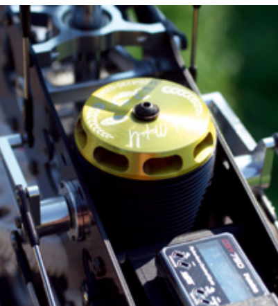
Der von uns gewählte Scorpion 4235-520 „Nick Maxwell“, der mit einem 12er-Ritzel kombiniert wurde
