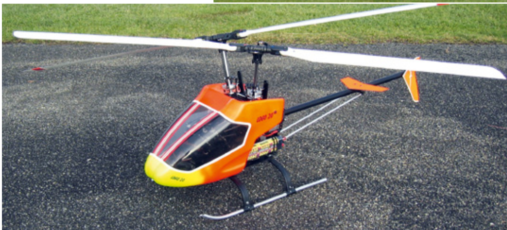
Abbildung 3: Elektro-Testbed. Daten: Rumpflänge: 1.200 mm, Rotordurchmesser: 2 x 1.420 mm, Antrieb: Elektromotor, Abflugmasse 5.800 g
