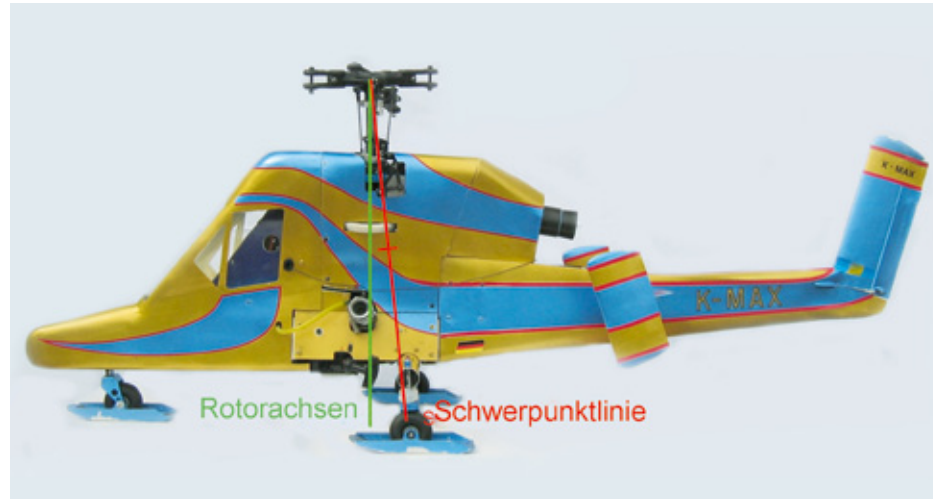
Abbildung 11: K-MAX Rückenschwimmer – Horizontale Vorwärtsgeschwindigkeit (maximale Antriebsleistung/maximales Pitch) Inhärentes Ab-Nick-Moment. Der Schwerpunkt befindet sich hinter der Rotorachse (Instabilität in der Längsachse). Rot: Schwerpunktlinien, Grün: Rotorachsen mit Antriebsleistung. Höhenleitwerk mit -25^\circ (Höhenrudereffekt) kompensiert das inhärente Ab-Nick-Moment
