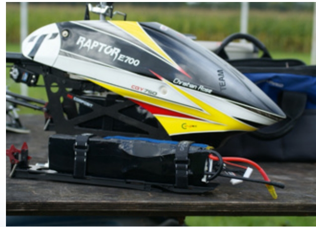
Die 12s-LiPos sind auf der Akkurutsche montiert und lassen sich dank des Schnellverschlusses bequem einsetzen
