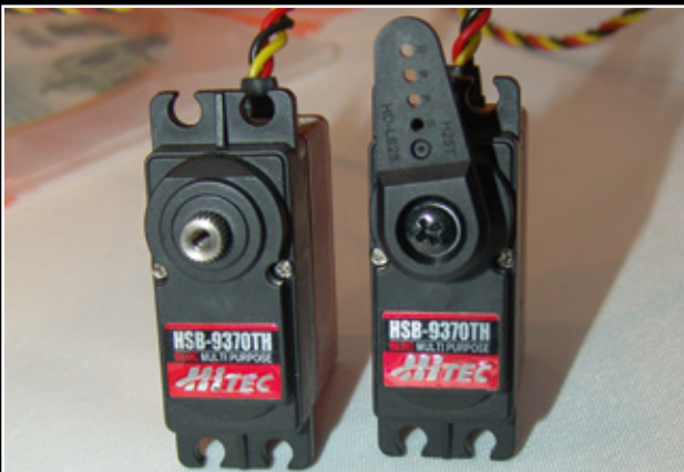
Insgesamt sechs Servotypen (Baureihen HSB-93xx und HSB-94xx) gibt es von HiTEC, die mit der stromsparenden Power Miser-Elektronik ausgestattet sind. Hier das mit Kunststoffgehäuse ausgestattete HSB-9370TH
