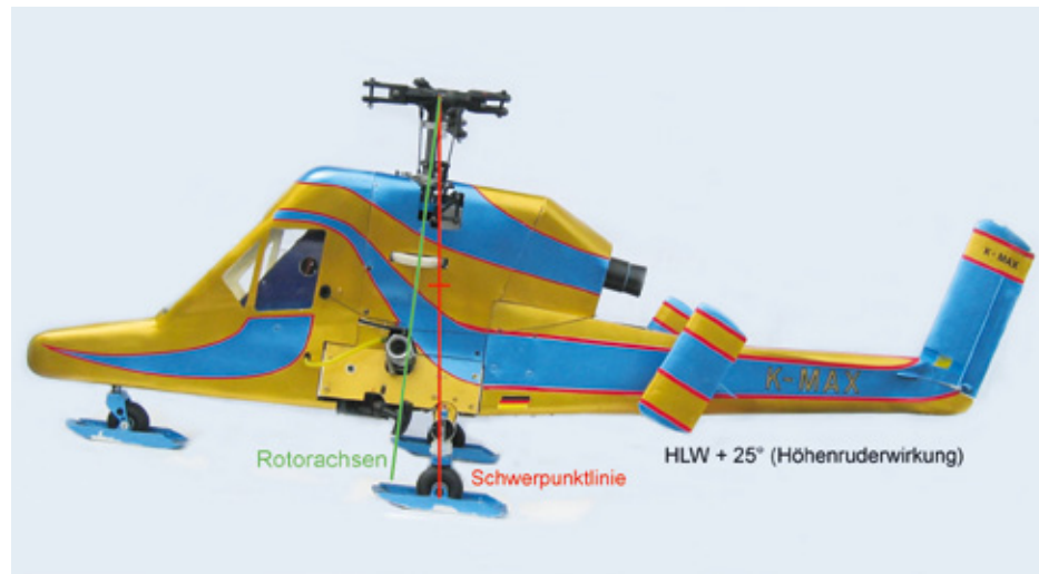
Abbildung 12: K-MAX Rückenschwimmer – Steiler Landeanflug/Autorotation (Antriebsleistung geht gegen Null) Die Rotoren drehen entgegengesetzt zum Brustschwimmer. Inhärentes Ab-Nick-Moment. Rot: Schwerpunktlinie, Grün: Rotorachsen ohne Antriebsleistung. Durch reduziertes beziehungsweise verschwindendes inhärentes Nickmoment wird das auftretende Auf-Nick-Moment durch Höhenleitwerkstellung von +25^\circ (Höhenrudereffekt) kompensiert
