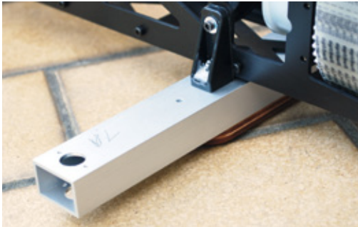
An der Mechanik verschraubte Kunststoff-Fahrwerksträger mit Bodenprofil
