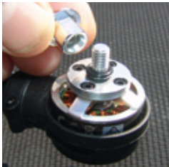
Stabile M5-Motorwellen und eine ausgeklügelte Luftschraubenbefestigung mit Flachstellen (siehe Text)
