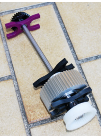
Hier die solide gefertigte 10-mm-Antriebswelle mit dem Kegelrad für den vorderen Rotor, die so montiert 814 Gramm wiegt. Das große weiße Innenzahnrad im Vordergrund ist die Kupplung zur Verbindungswelle, was in montiertem Zustand ...
