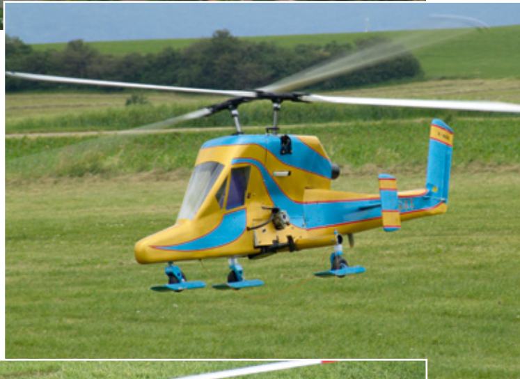
Abbildung 2: Kaman K-MAX. Daten: Nachbau-Maßstab 1:7,1, Rumpflänge: 1.200 mm, Rotordurchmesser: 2 x 1.520 mm, Antriebsmotor: Benzin 23 ccm, Abflugmasse: 9.500 g
