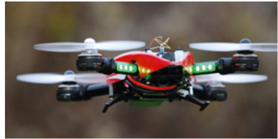
Die innen halbrund profilierten und am Alu-Rohr verklebten LED-Streifen helfen sehr gut bei der Lageerkennung
