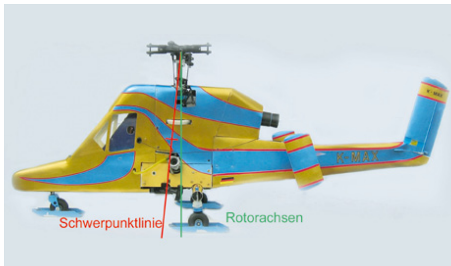
Abbildung 5: K-MAX Brustschwimmer – Start- und Landeposition: Rot: Schwerpunktlinie, Grün: Rotorachsen ohne Antriebsleistung. Der Schwerpunktlinie liegt 6^\circ vor den beiden Rotorachsen. Das Höhenleitwerk (HLW) steht auf -25^\circ , da der Pitch/Gas-Knüppel und damit das HLW auf niedrigstem Wert eingestellt ist.
