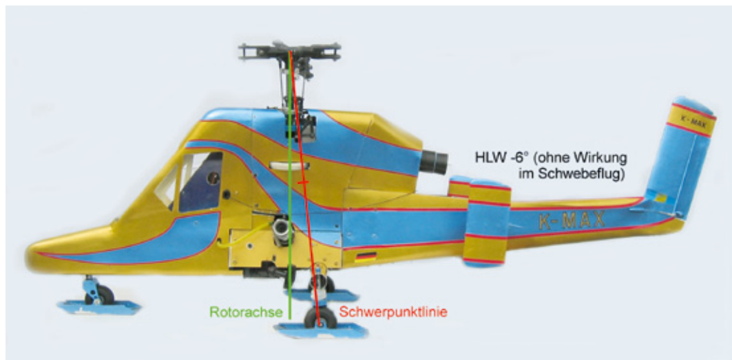
Abbildung 10: K-MAX Rückenschwimmer – Start-, Lande- und Schwebeflug-Position. Die Rotoren drehen entgegengesetzt zum Brustschwimmer und erzeugen ein inhärentes Ab-Nick-Moment. Aus diesem Grund muss der Schwerpunkt hinter der Rotorachse liegen. Dies ergibt eine Instabilität in der Längsachse. Grün: Rotorachsen mit Antriebsleistung. Rot: Schwerpunktlinie. HLW -6^\circ
