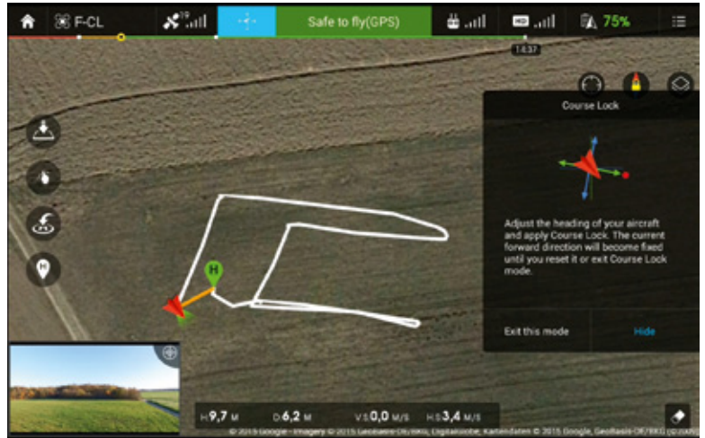
Abbildung 3: Testflug im F-CL-Mode zeigt eine ordentliche, aber nicht perfekte Funktion bei Course Lock
