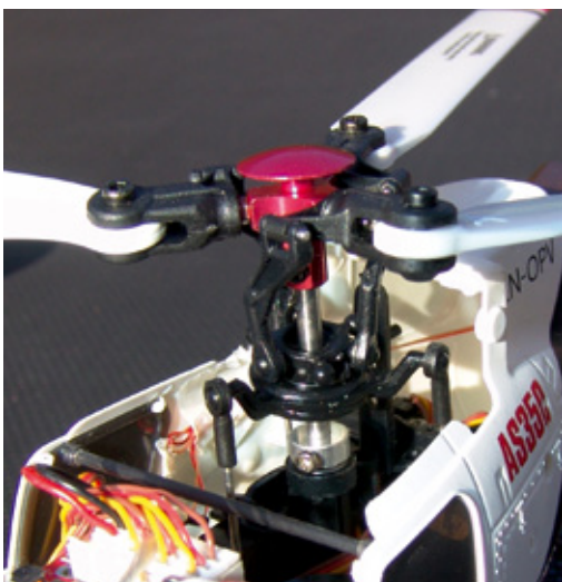
Der Dreiblatt-Hauptrotor mit seinem Metall-Zentralstück und den Y-Anlenkgestängen. Die drei winzigen Taumelscheiben-Servos sitzen direkt unter der Taumelscheibe
