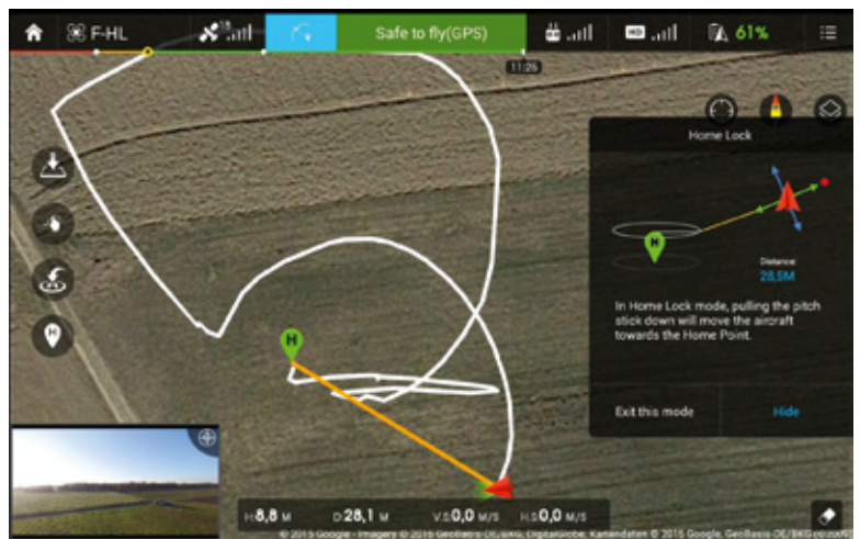
Abbildung 4: Testflug im F-HL Mode zeigt eine nicht perfekte Funktion bei Home Lock. Halten von Roll liefert nur angedeutet Kreise um Home
