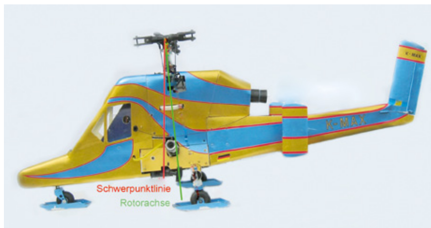
Abbildung 6: K-MAX Brustschwimmer – Vertikal- und Schwebeflug. In der Startphase neigt sich der Heli zuerst nach vorne und durch Steigerung der Antriebsleistung (Erhöhung des Pitch/Gas) erhöht sich auch das inhärente Nickmoment. Das Höhenleitwerk muss auf 0^\circ eingestellt sein. Bei Erhöhung von Pitch/Gas im vertikalen Steigflug muss das ansteigende inhärente Nickmoment mit dem Nick-Knüppel „ziehen“, beim vertikalen Sinkflug mit dem Nick-Knüppel „drücken“ ausgeglichen werden
