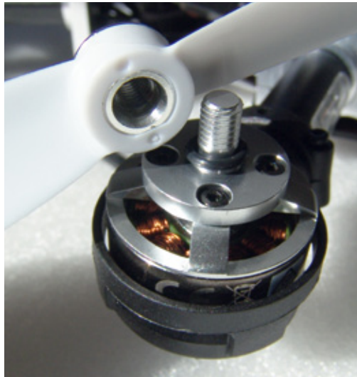
Montageablauf: Spinner in Luftschrauben einstecken und Einheit bis zum O-Ring aufdrehen
