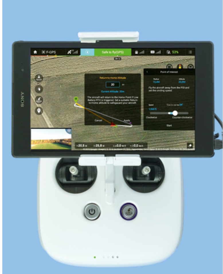
Kompakte, auch bei hellem Licht noch nutzbare Bodenstation. Die Helligkeit des Video Downlinks unbedingt mit dem rechten Drehrad am Sender einstellen
