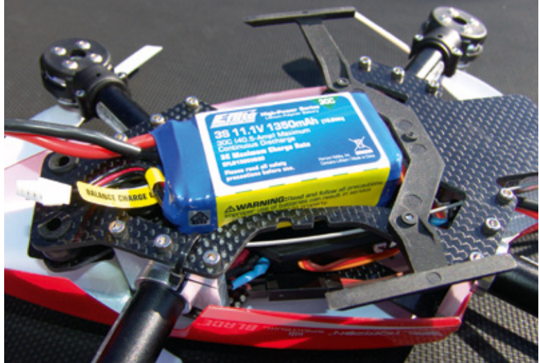
So sitzt der Akku im Schacht. Auf dem Bild fehlt nur noch der sichernde O-Ring (gehört zum Lieferumfang)
