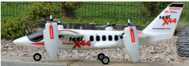
Im Helimodus stehen die Motorgondeln etwa 90 Grad nach oben
