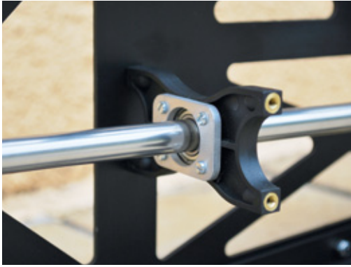
Die Edelstahlwelle ist fünf Mal in der Mechanik gelagert
