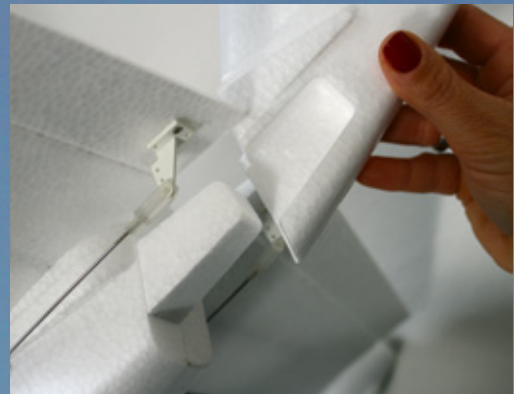
Die serienmäßigen Passungen an Seitenleitwerk und Rumpf garantieren einen perfekten Sitz und eine stabile Verbindung
