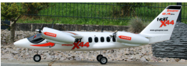
Im Flugmodus stehen die Motorgondeln je nach Einstellung fast parallel zu den Tragflächen
