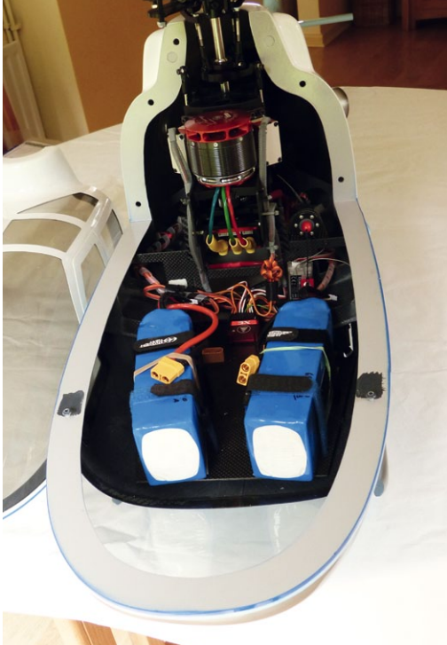
Die beiden 6s-LiPo-Packs werden auf der Bodenplatte fixiert
