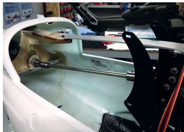
Blick auf die Heckrotor-Antriebswelle mit Kardankupplung
