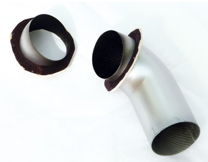
Die Abgasrohre wurden erst nach dem Lackieren eingeklebt
