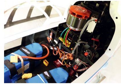
Blick aufs Flybarless-System sowie Empfänger und SPS-Magnetschalter. Die Motorkabel sind direkt mit dem Kosmik verschraubt
