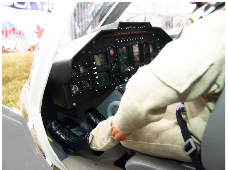
Das Cockpit erstellte Stijn mit Hilfe eines 3D-Druckers, verzichtete jedoch aus Gewichtsgründen auf Instrumentenbeleuchtung
