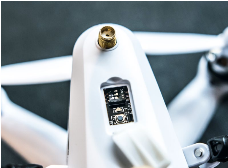
Unter dem Deckel verbergen sich die DIP-Schalter für den Kanalwechsel des FPV-Senders
