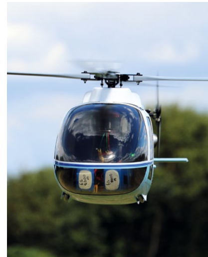
Die Frontansicht mit eingezogenen Kufen verdeutlicht die schmale, strömungsgünstige Silhouette
