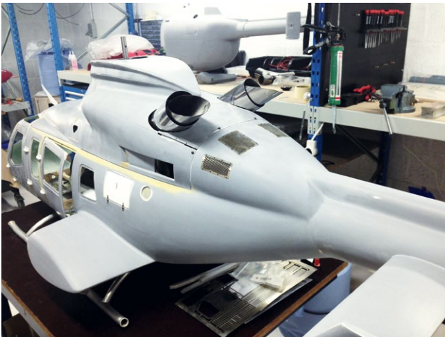
Die Lüftungsgitter im hinteren Bereich der Zelle unterstreichen das vorbildgetreue Erscheinungsbild der Bell 430, beugen aber auch einem eventuellen Hitzestau vor
