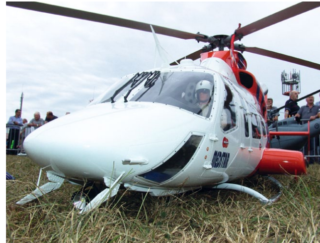
Die Front der Bell 430 mit Kabel-Cuttern und Suchscheinwerfer im Bodenbereich
