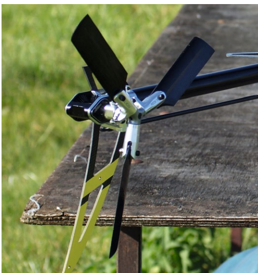
Zu den Modifikationen am T-Rex 700X gehört auch der Dreiblatt-Heckrotor mit den 105 Millimeter langen Heckrotorblättern
