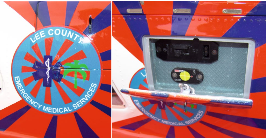
Hinter dem auf der Revisionsklappe aufgebrachtem „Lee County“-Wappen verbergen sich die Schalter für RC-Anlage und Beleuchtung
