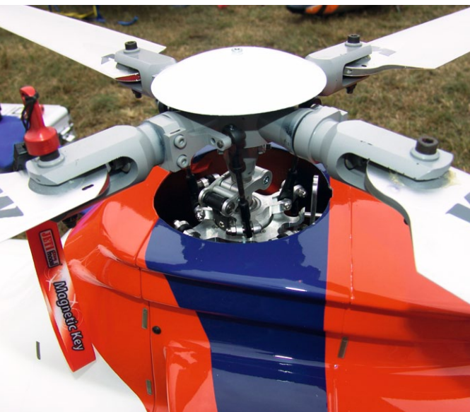
Das linksdrehende Vierblatt-Hauptrotorsystem, ...
