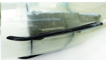
... die Kufenrohre am Rumpfausschnitt anliegen
