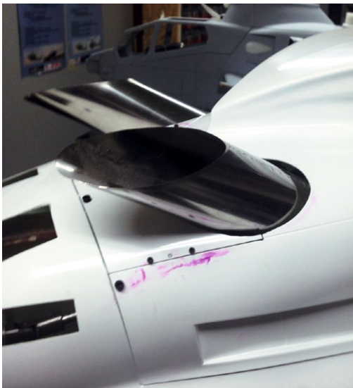
Unmittelbar hinter dem Austritt der Abgasrohre wurde der Domdeckel getrennt, um die Demontage zu vereinfachen
