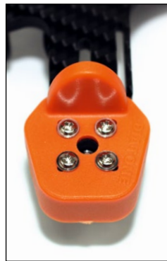
Die Motoren sind mit jeweils vier Schrauben mit dem Kunststoff-Schutz am Arm montiert
