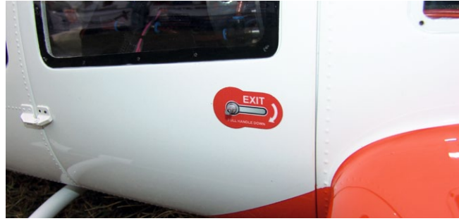
Aufgebrachte Türgriff-Imitationen. Die Befestigung der Türen erfolgt mit Scharnieren und Magneten
