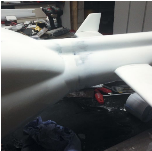
Der Heckausleger wurde mit dem Rumpf verklebt
