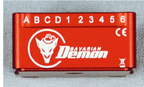
Die Beschriftung der Anschlüsse ist vorn am Gehäuse angebracht. Leider fehlt eine Bezeichnung der Einsteckrichtung
