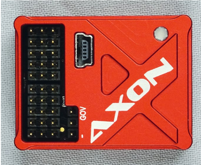
Servobuchsen, RC-Eingänge sowie der USB-Anschluss befinden sich oben im rot eloxierte Alu-Gehäuse
