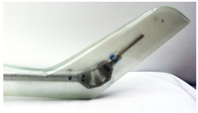
Und so sitzt die Einheit (provisorisch) im Rumpf. Auf der X-Markierung liegt die Heckrotor-Ausgangswelle
