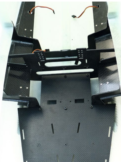
Die verschraubte Bodenplatte gibt die Position des auf Anschlag sitzenden Mechanik-Frontspants vor
