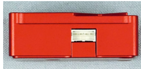
Auf der echten Seite befindet sich der Anschluss für den eigenen AXON-Sensorbus. Man darf gespannt sein, was bavarianDEMON hier noch alles bringt
