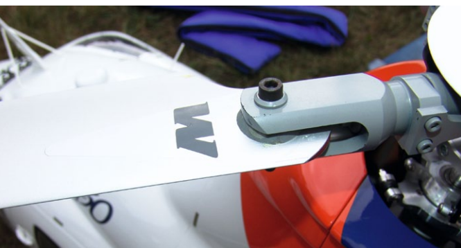
... kombiniert mit Aluminium-Hauptrotorblättern (M-Blades)
