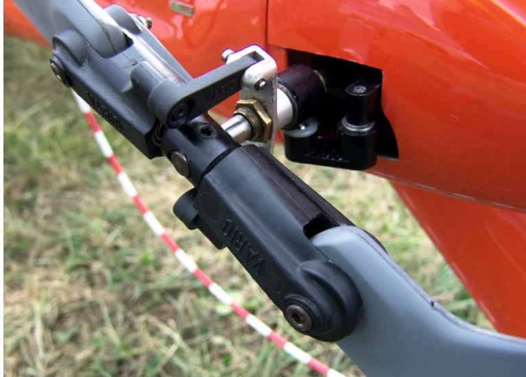
Der Vario Zweiblatt-Heckrotor mit ...
