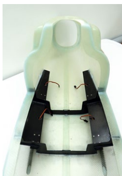
Der gesamte Kufen-Mechanismus ist bereits eingebaut und perfekt justiert. Die entsprechenden vier Servos sitzen unter den CFK-Langsträgern
