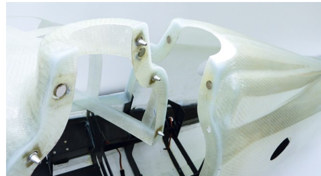
Zusätzlichen Halt bieten Magnete ...
