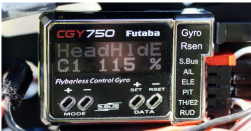
Heading Hold A/E: Die Head-Hold-Parameter dienen zur Einstellung einer konstanten und gleichmäßigen Drehrate der zyklischen Achsen. Hier haben wir im Schweben die beiden Parameter etwas erhöht, im Kunstflug jedoch auf der Standard-Einstellung belassen.
