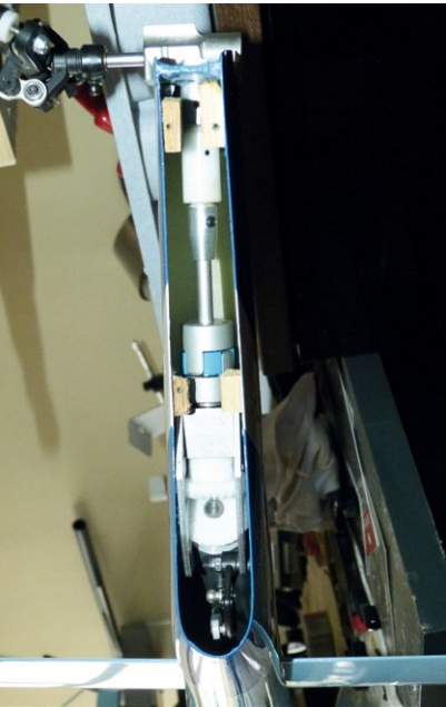
Umlenk- und Heckgetriebe sind samt Antrieb und Anlenkung montiert
