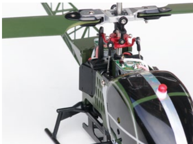
Zum Antrieb der beiden Hauptrotoren sind zwei Bürstenmotoren verbaut. Der untere Rotor wird über die Metall-Taumelscheibe angelenkt (Funktionen Nick und Roll)
