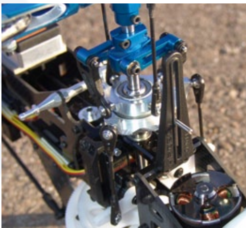
Blick auf die Ganzmetall-Taumelscheibe sowie der Führung mittels Stahlbolzen
