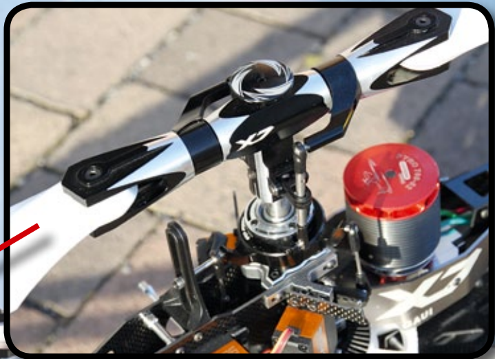
Das Ganzmetall-Flybarless-Hauptrotorsystem mit den am Zentralstück befestigten Ösen für die Gestängeführung (= Taumelscheiben-Mitnehmer)
