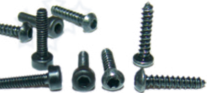
Die meisten vergüteten Stahlschrauben haben 1,5-mm-Innensechskant. Hier benötigt man qualitativ gutes Werkzeug, um die Köpfe nicht zu versauen
