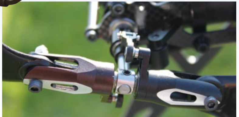
Detail der Stahlnabe inklusive der einteiligen Heckrotor-Blatthalter, in denen jeweils ein Radial- und Axiallager sitzt
