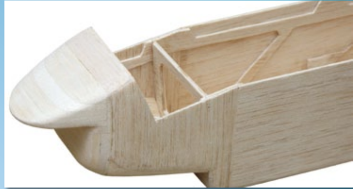
Die Nase entsteht aus 3 und 4 Millimeter dicken Balsabrettchen, die nach dem Ankleben und Trocknen in Form geschliffen werden
