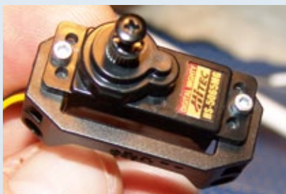
Eines der beiden HiTEC-Rollservos HS-5065MG, vorbereitet zum Einsetzen ins Chassis
