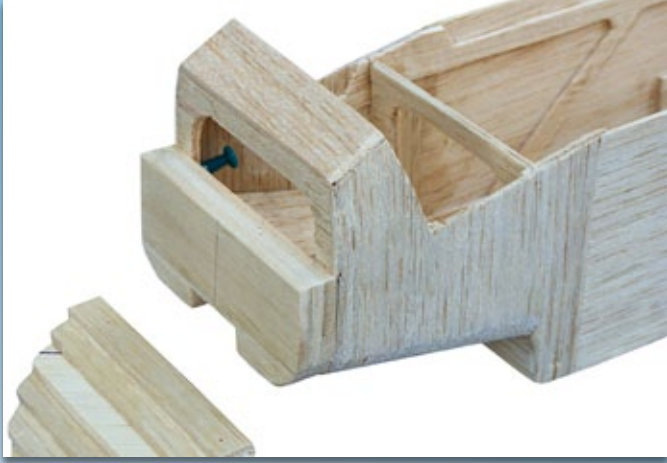
Die Nase entsteht aus 3 und 4 Millimeter dicken Balsabrettchen, die nach dem Ankleben und Trocknen in Form geschliffen werden
