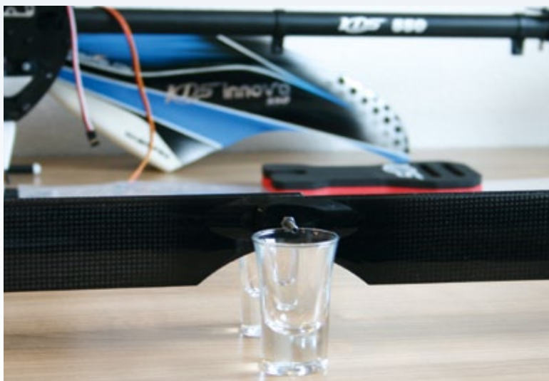
Das statische Wuchten der Rotorblätter funktioniert auch einwandfrei mit einfachen Hausmitteln (Wasserwaagenprinzip mit Hilfe von zwei Schnapsgläsern)
