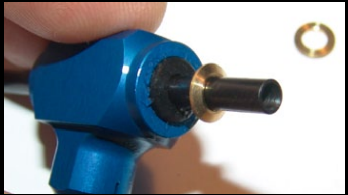
Details des Flybarless-Kopfs mit der im Text beschriebenen Dämpfung sowie den filigranen Passscheiben zum Anpassen des Spiels
