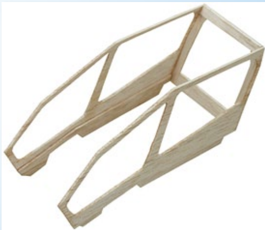
Die Kanzel ist später abnehmbar und besteht im Rohbau aus je zwei Seitenteilen und Spanten. Später sitzt sie formschlüssig auf der Rumpfwanne und wird von drei kleinen Magneten gehalten
