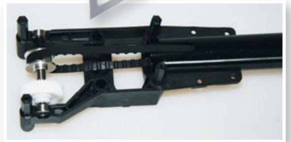
War der T-Rex vorher mit Starrwelle versehen, kommt jetzt im Rumpf ein via Zahnriemen angetriebener Heckrotor zum Einsatz. Hier der entsprechende Abtrieb
