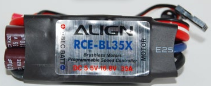
Mit seiner Strombelastbarkeit von 35 Ampere ist der BL35X für einen Job im 450er-Heli gut gerüstet. BEC ist selbstverständlich auch an Bord
