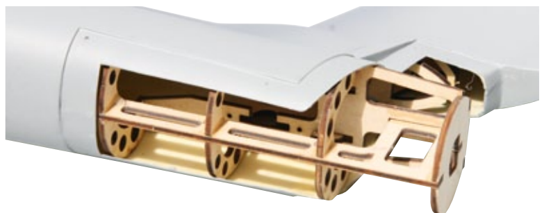
Hier die gesamte im Ausleger montierte Spanteneinheit zur Aufnahme der Zahnriemen-Umlenkrolle
