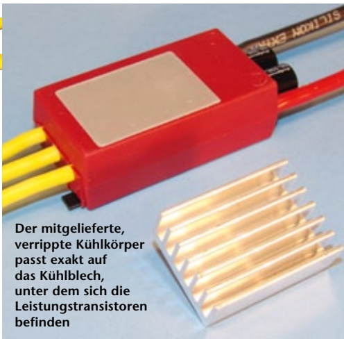
Bei aufgeklebtem Kühlkörper (Wärmeleitpaste oder gemäß Kontronik-Vorgabe dünnflüssiger Sekundenkleber) schafft der Heli Jive mehr als den angegebenen Dauerstrom von 120 Ampere
