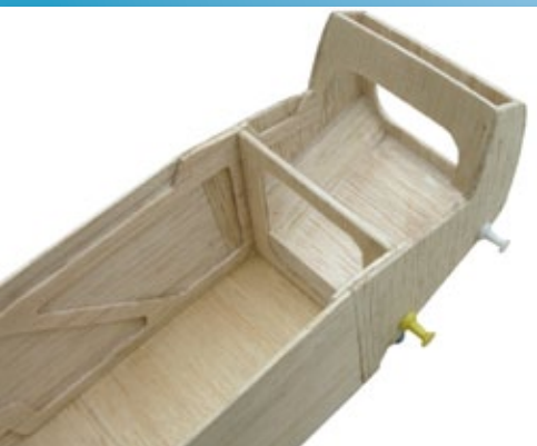
Der Vorderrumpf von oben. Der vornsitzende Doppelspant bildet später den Übergang zur Rumpfnase
