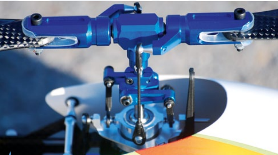
Der Zweiblatt-Flybarless-Hauptrotorkopf ist aus Ganzmetall gefertigt und entspricht dem hohen Hirobo-Qualitätsstandard. Der Taumelscheiben-Mitnehmer ist kugelgelagert und muss korrekt auf der Rotorwelle positioniert werden
