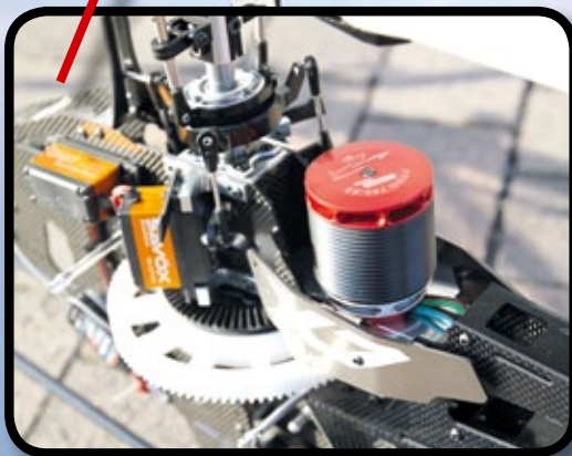
Am massiven Aluminium-Motorträger sind beidseitig Kühlbleche angebracht, um ausreichende Wärmeabfuhr zu gewährleisten. Deutlich zu erkennen sind auch das schrägverzahnte Hauptzahnrad und das Tellerrad des Heckantriebs
