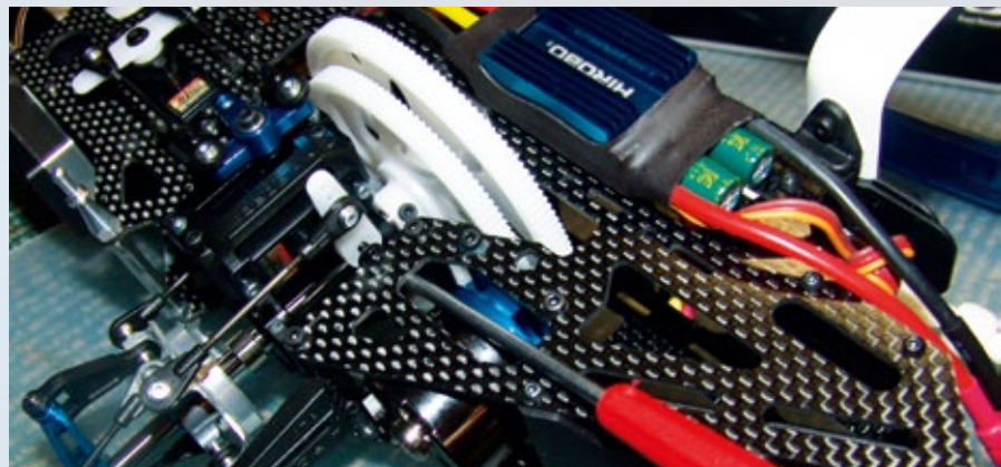
Extrem service-freundlich: Sogar die Schrauben der Abtriebshebel lassen sich ohne Demontage der Servos erreichen
