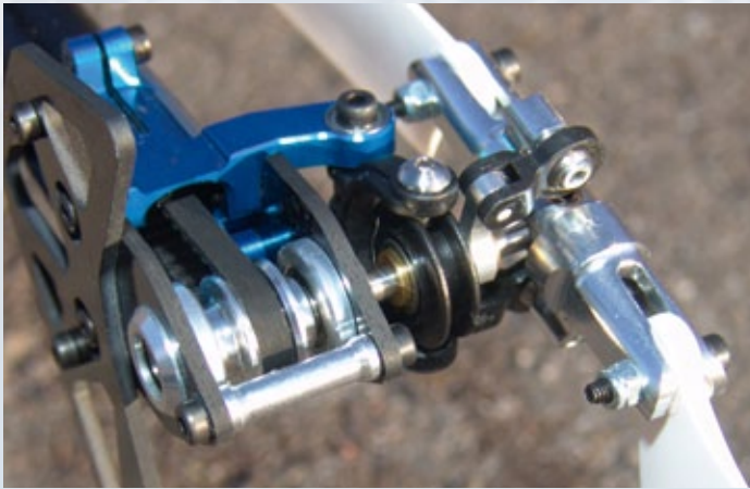
Der robuste Heckrotor mit Metall-Korpus, CFK-Seitenteilen, der doppelten Schiebhülsen-Anlenkung sowie den Ganzmetall-Blatthaltern
