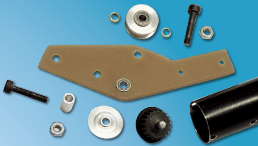
Die Bauteile der im Text beschriebenen Heckriemen-Umlenkung. Die Aluhülse (links im Bild) und das aufgeklebte Sperrholzstück (rechts) dienen als Abstandshalter zwischen den beiden GFK-Platten
