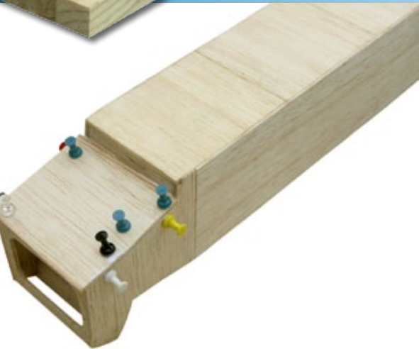
Der kastenförmige Rumpf von unten. An dem schrägen Brettchen, das hier während des Trocknens von Stoßnadeln gehalten wird, hängt später die Kanone
