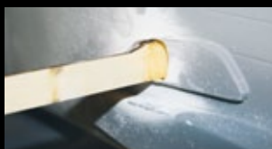
Der eingelassene Trägerspant für die Stummelflügel
