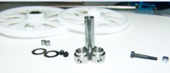
Details des Flybarless-Kopfs mit der im Text beschriebenen Dämpfung sowie den filigranen Passscheiben zum Anpassen des Spiels
