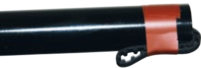
Hilft bei der Montage – das Fixieren des Zahnriemens am Ausgang des Heckrohrs mit Klebeband
