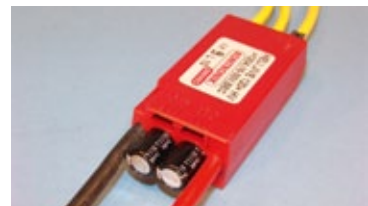
Der Heli Jive besitzt ein leistungsstarkes BEC und zwei Empfängerzuleitungen, um den Spannungsabfall zum Empfänger niedrig zu halten
