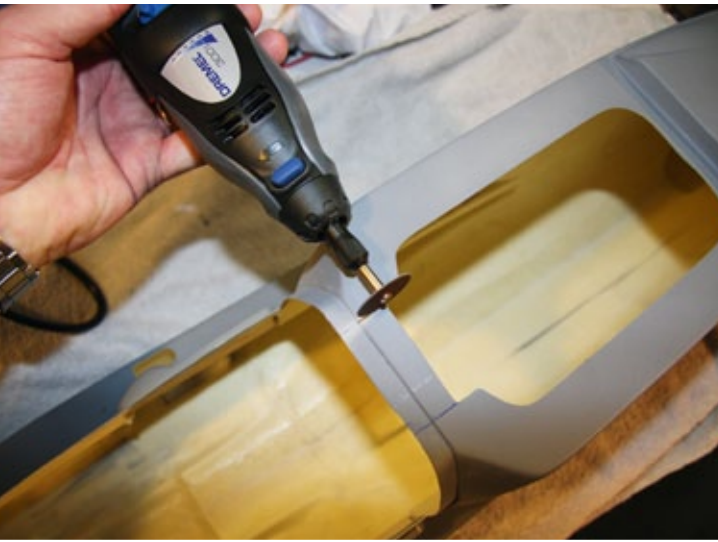
Um die Mechanik einfacher in den Rumpf einsetzen zu können, wurde der Mittelsteg des Doms herausgeschnitten
