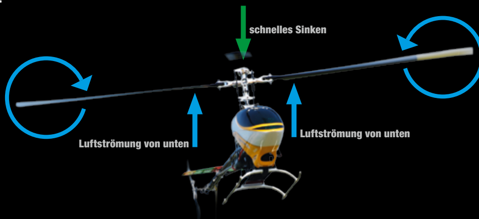
Die blauen Ringe skizzieren den gefährlichen Wirbelring beim schnellen Abstieg; in diesem Bereich liefert der Rotorkreis keinen Auftrieb mehr. Im Innenbereich geht durch Strömungsabriss ebenfalls Auftrieb verloren
