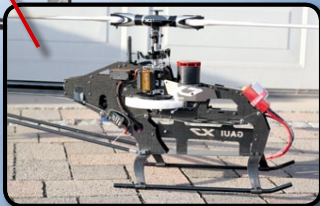
Die Seitenansicht verdeutlicht den klassischen Aufbau mit zweiteiligem CFK-Chassis und frontseitig angeordnetem Motor. Der Akkuschaft besitzt einen Mittelsteg zum einfachen Befestigen der LiPo-Antriebsakkus (zwei in Serie geschaltete 6s-Packs)
