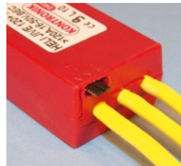
Zum Einleiten der Modus-Programmierung beziehungsweise Einlernen der Wege wird der Jumper (Kurzschlussstecker; schwarzer Pin) gezogen. Damit geht der Jive in den Programmiermodus
