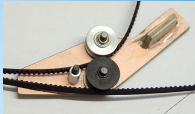
Hier die teilmontierte Heckriemen-Umlenkung mit provisorisch eingelegtem Zahnriemen zur Funktionsdarstellung
