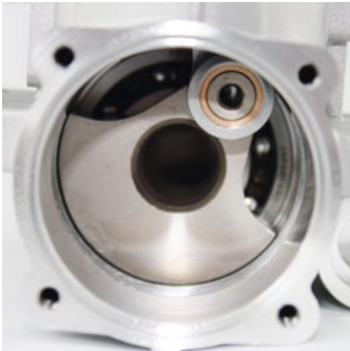
Blick auf die Kurbelwellen-Wange und das hintere Lager, das massiver ausgelegt wurde als beim O.S. MAX 91
