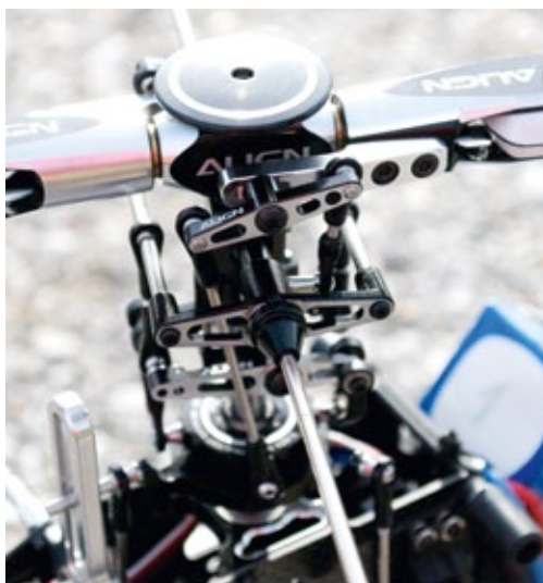
Am Anlenkhebel des Blatthalters lässt sich der Bell/Hiller-Mischer an drei verschiedenen Positionen montieren, um die Delta-Drei-Rücksteuerung beeinflussen zu können. Deutlich zu erkennen ist auch die stabile Metall-Steuerkulisse der Stabstange
