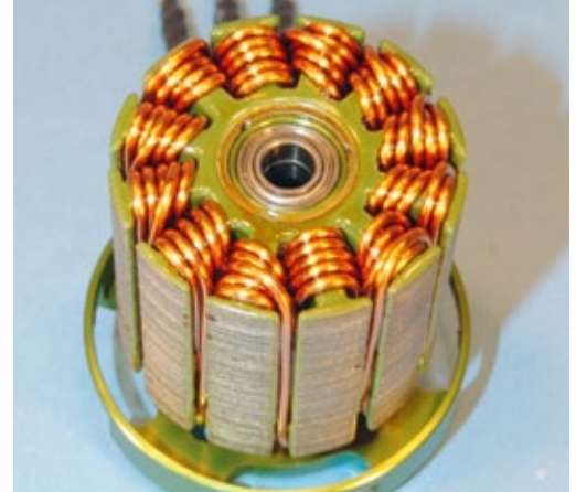
Die Einzeldraht-Wicklung wurde von Hand eingelegt und sehr sorgfältig und mit wenig Harz vergossen. Die hintere Kugellagerung ist doppelt ausgeführt
