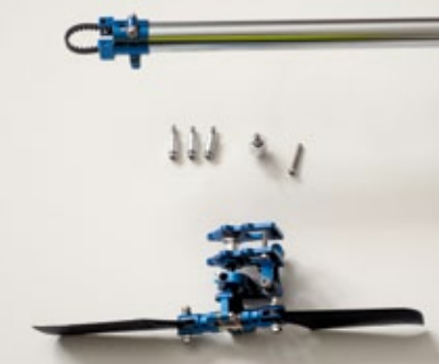
Der fertig zum Einbau vorbereitete Heckrotor samt Heckrohr
