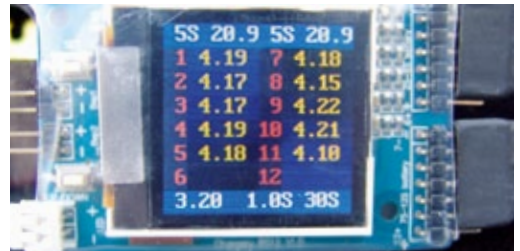
Einsatz des BS12 im Three Dee Rigid mit einem 10s-LiPo. Zu erkennen sind: Statusanzeige der aktuellen Einzelspannungen sowie aktuelle Einstellungen (3,2 V Warnspannung, 1 s Verzögerungszeit und 30 s Warndauer)
