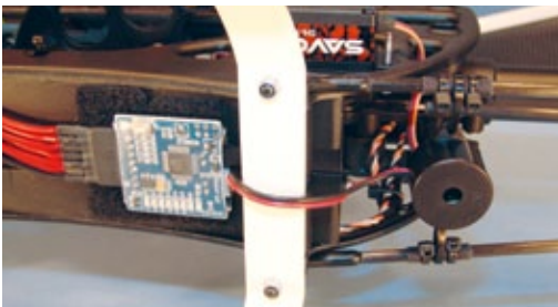
Der BS6 im Logo 400 SE: Der Piezo-Summer ist so zwischen den Heckstreben befestigt, dass er seinen Alarmton optimal nach hinten unten abgeben kann
