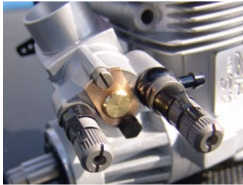
Der Vergaser des O.S. MAX 105 lässt sich relativ einfach einstellen. Mit der kleinen Leerlaufschraube in der Mitte wird die gesamte Düsenstock-Kulisse verstellt. Vollgas-(rechts) und Mittengas-Nadel (ganz links) haben jeweils O-Ring-Abdichtungen und Bügel-Arretierungen
