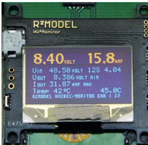
Das Display mit den Live-Daten: BEC-Spannung, BEC-Strom, Eingang-/Ausgangsspannung und Temperatur (Minimum/Maximum-Werte)
