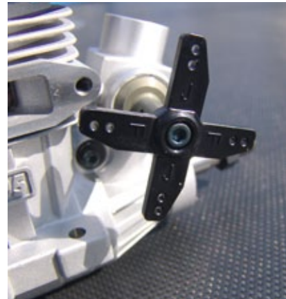
Der Gas-Verstellhebel lässt sich am Küken in beliebiger Position festschrauben
