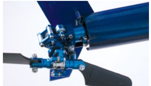
Die Befestigung des Heckrotorgehäuse ist auch nach der Montage noch gut zugänglich
