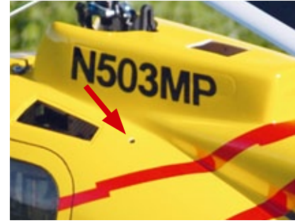
Unter der „3“ ist eines der beiden kleinen Löcher zu erkennen, durch die sich der verlängerte Inbusschlüssel zur hinteren Verschraubung der Mechanik stecken lässt
