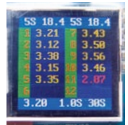
Nach Drücken des Tasters können die niedrigsten, während dem Flug gespeicherten Spannungen der einzelnen Zellen abgelesen werden. Es lässt sich erkennen, wie stark die (relativ alten) Zellen unter Last tatsächlich driften. Die Zelle/Spannung, die den Alarm ausgelöst hat, wird rot hervorgehoben (hier 2,87 V)
