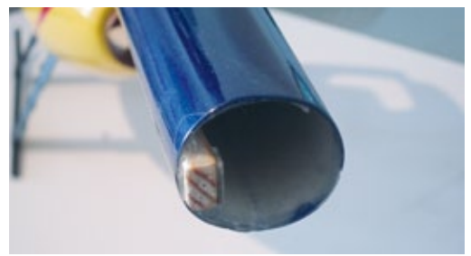
Der Heckausleger wurde innen mit einer Kiefernleiste verstärkt. Hier greift später die Schraube der Leitwerks-Befestigung ein
