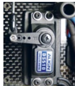
Aufgrund der im CFK-Chassis eingesetzten Kunststoff-Aufnahmen lassen sich die Servos leicht und einfach montieren
