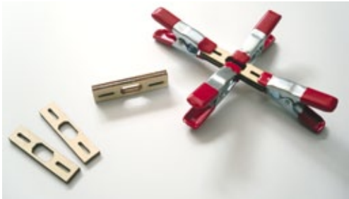
Um die KDS-Mechanik in der korrekten Höhe im Rumpf zu platzieren, mussten entsprechende Adapterklötze hergestellt und an der Lagerleiste des Chassis verschraubt werden
