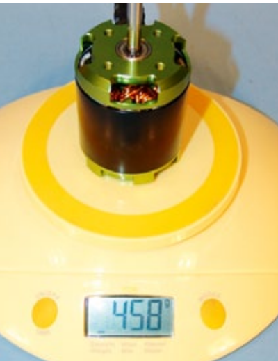
Der BSM-5065 pro bringt 458 Gramm auf die Waage und bewegt sich damit im unteren Bereich seiner Mitbewerber
