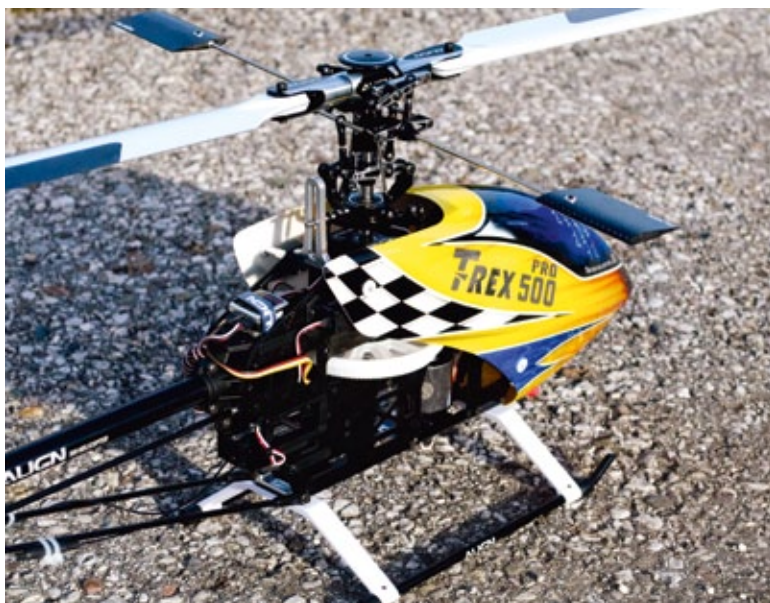
Die lackierte Kabinenhaube wird an vier Punkten mit dem Chassis verbunden. Die Taumelscheiben-Führung übernimmt neuerdings ein gefrästes Alu-Exemplar. Das Gyro-System sitzt über der Heckrohr-Aufnahme
