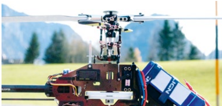
Die Seitenansicht verdeutlicht den klassischen Aufbau, bestehend aus zweiteiligem Chassis mit vorne sitzendem Akku und Motor
