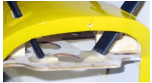
Die engültige Verklebung der in der Bodenplatte eingelassenen Kufenbügel erfolgte mit UHU plus endfest 300
