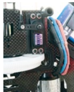
Für eine angenehmes Betriebsgeräusch sorgt das schrägverzahnte Hauptgetriebe
