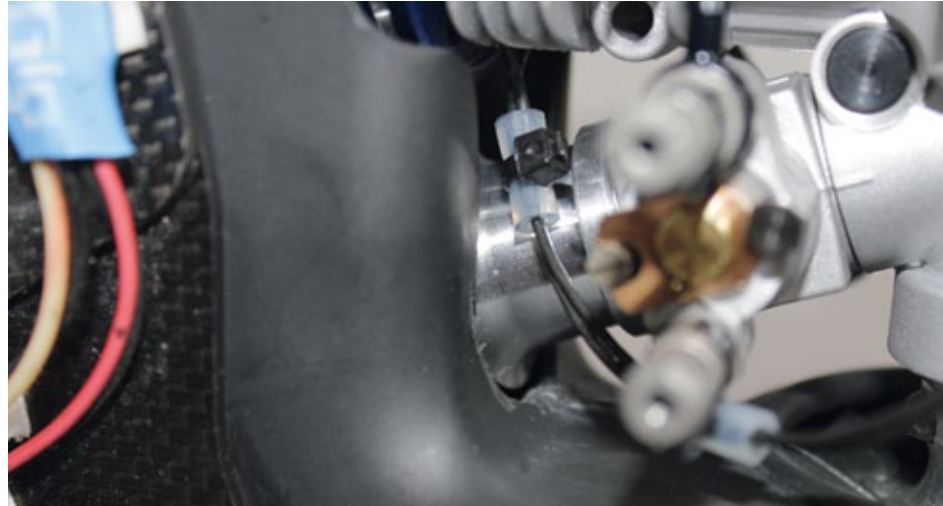
Der zum Lieferumfang gehörende „Velocity Stack“ – das ist ein Lufteinlass aus Aluminium, die für erhöhte Luftzufuhr und Strömungsgeschwindigkeit sorgen soll
